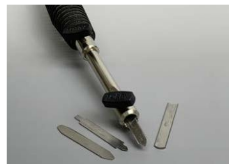
Das Chatter Tool wird mit zwei 1,6-mm-dicken Federstahlblättchen geliefert. Ich habe für schmale Muster mit Winkelschleifer und Schleifbock zwei weitere Blättchen aus einem Bandsägeblatt (ein Millimeter stark) gefertigt (links im Bild).
