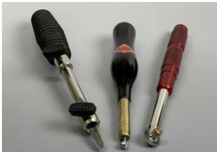
Von links nach rechts: Chatter Tool (älteres Modell, Hersteller: Robert Sorby), Decorating Elf (Hersteller: Henry Taylor) und Mini Spiralling-System (Hersteller: Robert Sorby).
