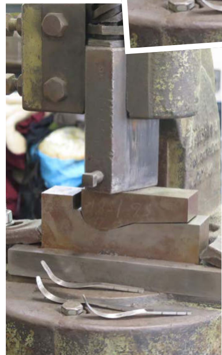
Diese handbetriebene Spindelpresse biegt die Hakenmesser in Form. Das geht erstaunlicherweise sogar in kaltem Zustand.
