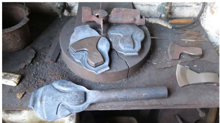
Plätzchen backen in groß: Die Beile werden in der Ober- und Unterform im geschlossenen Gesenk geschmiedet. Nur dass der Teig hier ein orangeglähender, 35 mm starker Rundstahl ist. Dieser Axtkopf ist bereits fertig „gebacken“.
