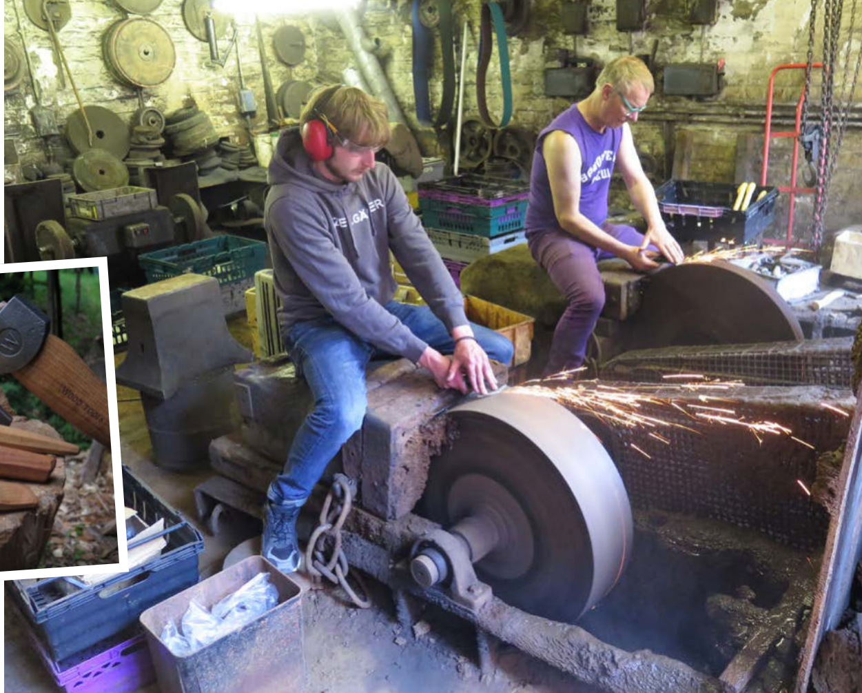
Herz der Schleiferei sind die beiden großen Wassersteine, die erstaunlich ruhig laufen und enorm schnell arbeiten. Sie bringen die Klinge in Form. Den sauberen Hohlsliff frei Hand herzustellen, erfordert hohe Fingerfertigkeit der Schleifer.
