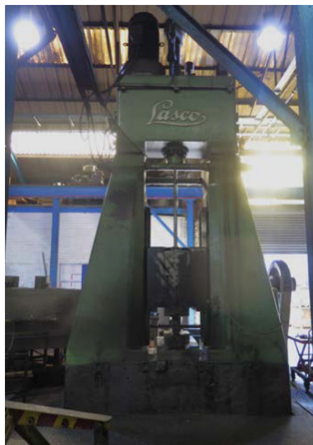
Masse hat Klasse: Der 57-Tonnen-Fallhammer braucht drei Schläge, um den Rundstahl in der Form in ein Beil zu verwandeln. Der glühende Rundstahl wird dabei vom Schmied von Hand eingelegt – ein nicht ungefährlicher Arbeitsschritt, der viel Erfahrung erfordert.
