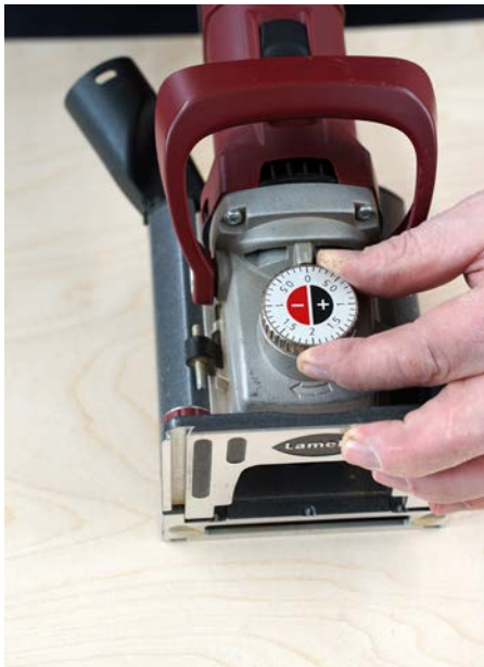
Die Fräshöhe kann durch Drehen am Einstellrad um plus/minus 2 mm angepasst werden.
