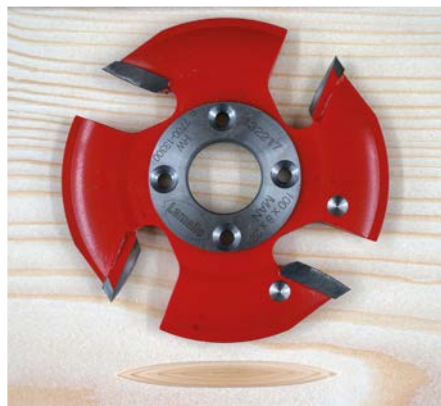
Um Harzgallen auszubessern, kommt der Ast-spot-Fräser (auch Harzgallen- oder Schiffchenfräser genannt) zum Einsatz. Er hat einen 5 mm dicken Grundkörper und vier Zähne.
