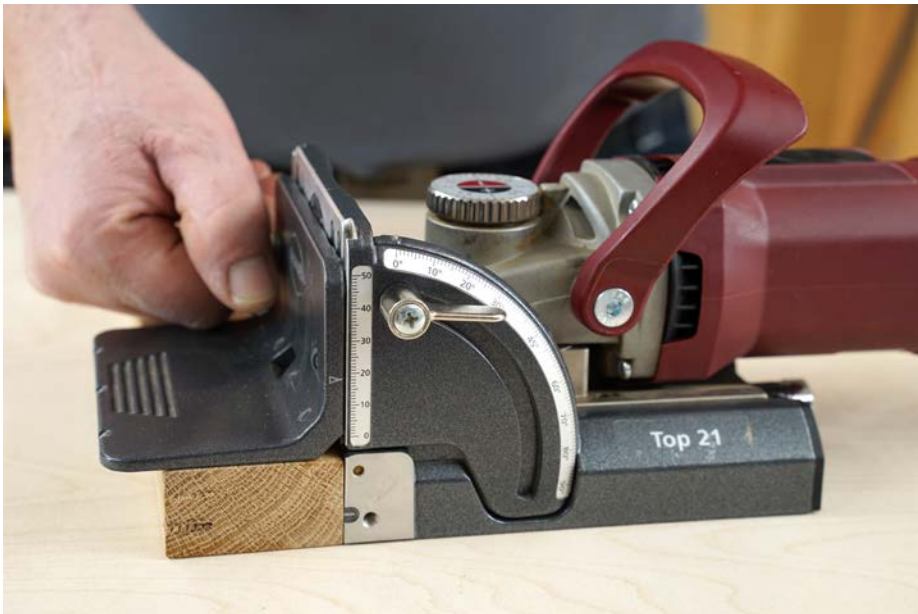
Eine weitere Möglichkeit, die Fräshöhe der Maschine entsprechend anzupassen, bietet der in einer Gratnut montierte Tisch der Geräte von Lamello.
