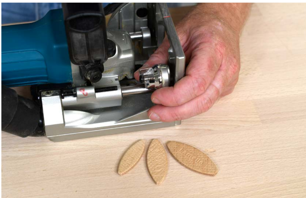
Über einen Drehknopf kann die Frästiefe jeder Flachdübelfräse entsprechend der Flachdübelgröße angepasst werden.
