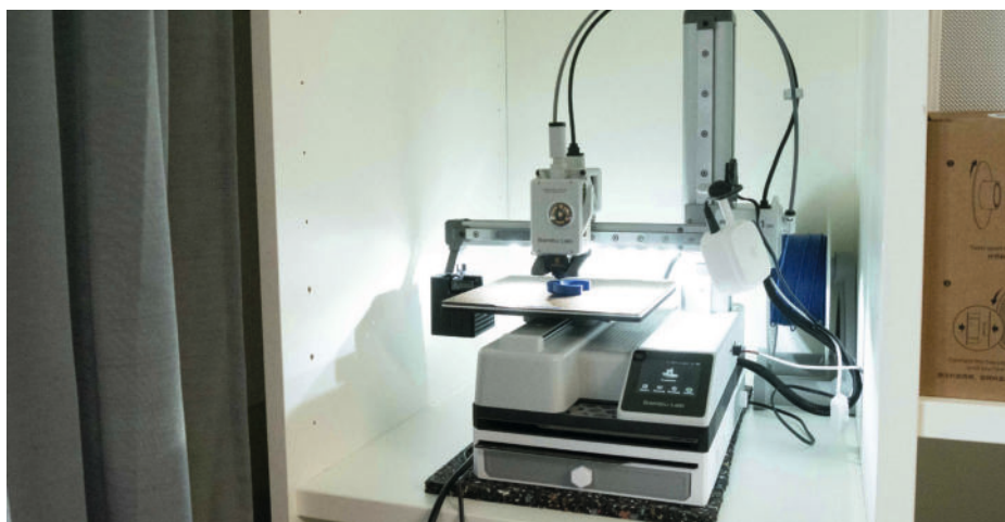
Aufbau eines kleinen 3D-Druckers für rund 200 Euro (BambuLab A1 mini): Der Druckkopf wird an seinem Arm nach links und rechts gesteuert (X-Achse), und beides an der senkrechten Stütze auf und ab bewegt (Z-Achse). Bei diesem Modell ist die Druckplatte beweglich (vorne/hinten) und bildet so die Y-Achse. Rechts hinter dem Drucker ist die Filamentrolle zu sehen.
