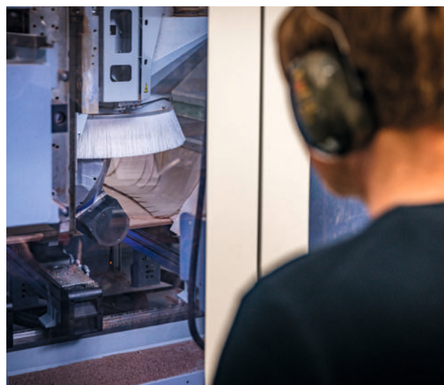
Auf fünf Achsen wird hier gefräst. Die Maschine kann den Fräser also auch in allen erdenklichen Winkeln kippen.
