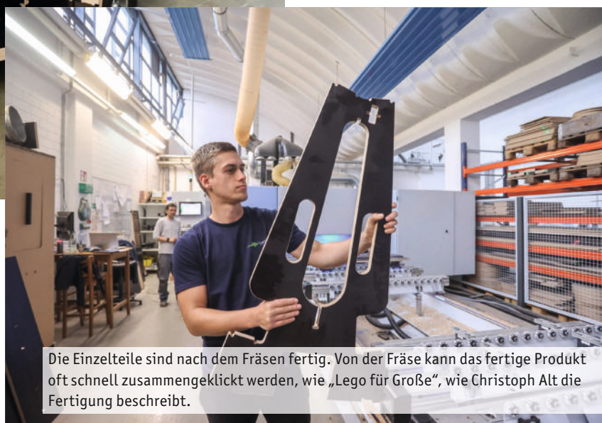
Auf fünf Achsen wird hier gefräst. Die Maschine kann den Fräser also auch in allen erdenklichen Winkeln kippen.
