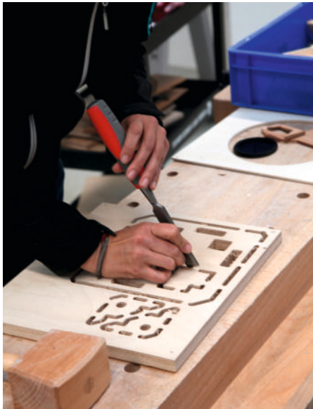
Ein wenig Handarbeit: Nach dem Fräsen werden die Haltestege mit dem Stemmeisen entfernt.
