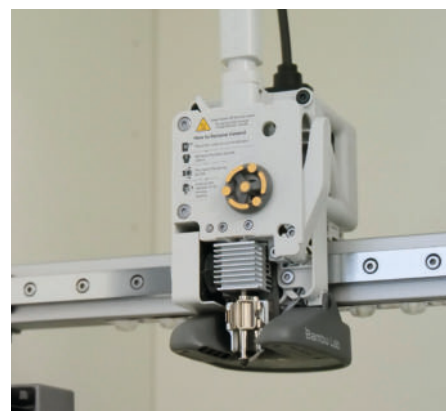
Das Herz des Druckers bildet die auf über 200 Grad aufgeheizte Düse. Hier kommt das durch Schläuche zugeführte Filament an, wird aufgeschmolzen und herausgepresst. Probleme beim Druck entstehen häufig an dieser Stelle, etwa, wenn der Kunststoff Fäden zieht.
