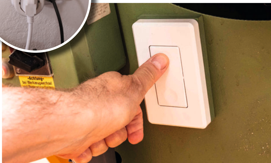
Eine einfache Fernsteuerungslösung läuft über eine Funk-Steckdose (für die Absaugung) mit mehreren Funkschaltern (platziert an den Maschinen). Allerdings muss man den Absaugschlauch beim Wechsel zwischen den Maschinen weiterhin umstecken.
