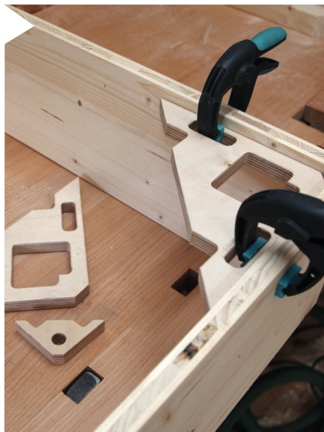
Nicht jedes Projekt muss 1:1 übernommen werden. Die Vorlage für diesen CNC-gefrästen Montagewinkel stammt von FlipFlopWoodworks und rwyong aus dem Shaperhub von Shapertools. Hier wurde sie noch etwas angepasst, um auch massivere Zwingen aufnehmen zu können.
