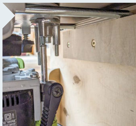
20 | Die Frästiefe/-höhe wird bequem über den Revolveranschlag der Oberfräse festgelegt.
