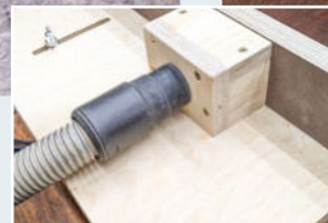
18 | Die Absaugung ist schnell gemacht. Die einzelnen Teile werden unter Zugabe von etwas Leim verschraubt. Ein 35-mm-Loch nimmt die üblichen Absaugschläuche auf.
