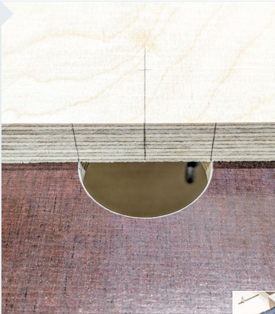
16 | Anhand des Lochs in der Tischplatte wird das Loch für die Aussparung im Anschlag angezeichnet und mit 35 mm gebohrt.
