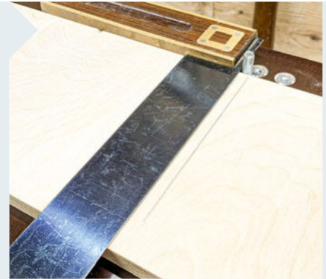
17 | Die Schlitz für die Verstellung des Anschlags werden anhand der Schrauben in der Platte angezeichnet und anschließend ausgefräst. Wenn Sie die Schlitz einen halben Millimeter breiter machen, lässt sich der Anschlag leichter verstellen.
