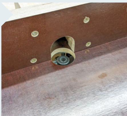
19 | Die Öffnung im Anschlag ist natürlich auch 35 mm dick. Hier sieht man auch, wie dicht die Oberfräse an die Tischplatte herangefahren werden kann.
