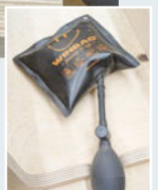
21 | Das Luftkissen liegt unter der Fräse in Position (Pfeil). Nun wird noch ein Sicherheitschalter mit Wiederanlaufschutz befestigt, und schon ist der Frästisch einsatzbereit.
