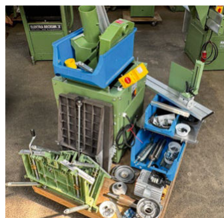
Wir begleiten einen Abricht-/Dickenhobel HC 260, das kleinste Modell, beim Wiederaufbau. Alle gereinigten Teile und wiederaufgearbeiteten Baugruppen liegen auf dem Rollwagen. Das Ordnungssystem mit seinen blauen Kisten ist für Klein unverzichtbar, um den Überblick zu halten.
