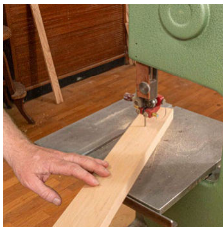
Wie gemacht für Schweifsnitte, aber auch keine Angst vor dicken Brettern: Hier mit einem 0,45 mm starken Sägeband (fünf Zähne pro Zoll) bestückt, ist die fast 60 Jahre alte Säge den meisten Werkstattaufgaben gewachsen.
