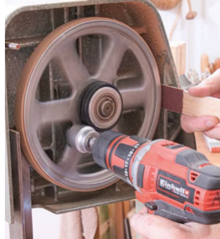
Ein Helfer mit Akkuschauber brachte die obere Rolle in Drehung. Hier muss man etwas improvisieren. Zur Kraftübertragung dienen die drei auf die Radnabe geschobenen O-Ringe.
