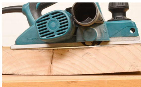
Bei geschüsseltem Holz sind oft mehrere Durchgänge „bergauf“ nötig, bis die komplette Hobelsohle aufliegt.
