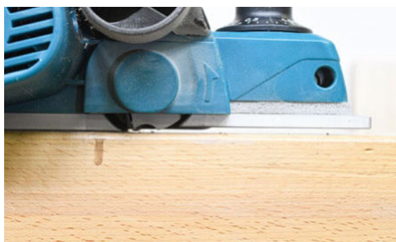
Hat nur die hintere Hobelsohle Kontakt zum Holz, greifen die Messer ins Leere.
