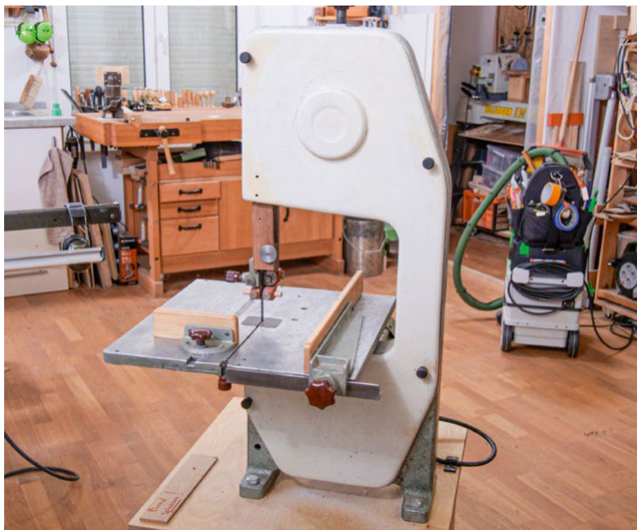
So war der Lieferumfang der Säge: Die weiße Schutzhaube mit abgeblättertem Lack ist der Normalzustand bei so alten Ulmia-Bandsägen. Glücksfall hier: Die beiden Anschläge waren dabei. Etwas über 400 Euro hat dieses Schätzchen auf dem Gebrauchtmarkt gekostet.
