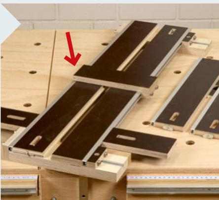
**18** | Mit einem simplen Anschlagbrett (Pfeil), das sich mit einem Kopplungsstück ebenfalls in den T-Nutschienen stufenlos verschieben lässt, können Sie ganz einfach den Verschiebeweg der Oberfräse begrenzen (zum Beispiel bei eingesetzten Nuten).
