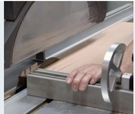
**1** Der Bau der Garderobe beginnt mit dem Abrichten und Hobeln der 35 mm starken Buchenbohlen. Präzises Arbeiten ist essenziell, da kleine Abweichungen die Hakenmontage erschweren. Anschließend sägen Sie die Riegel (Pos. 14 & 15) und Haken (Pos. 16) zu.
