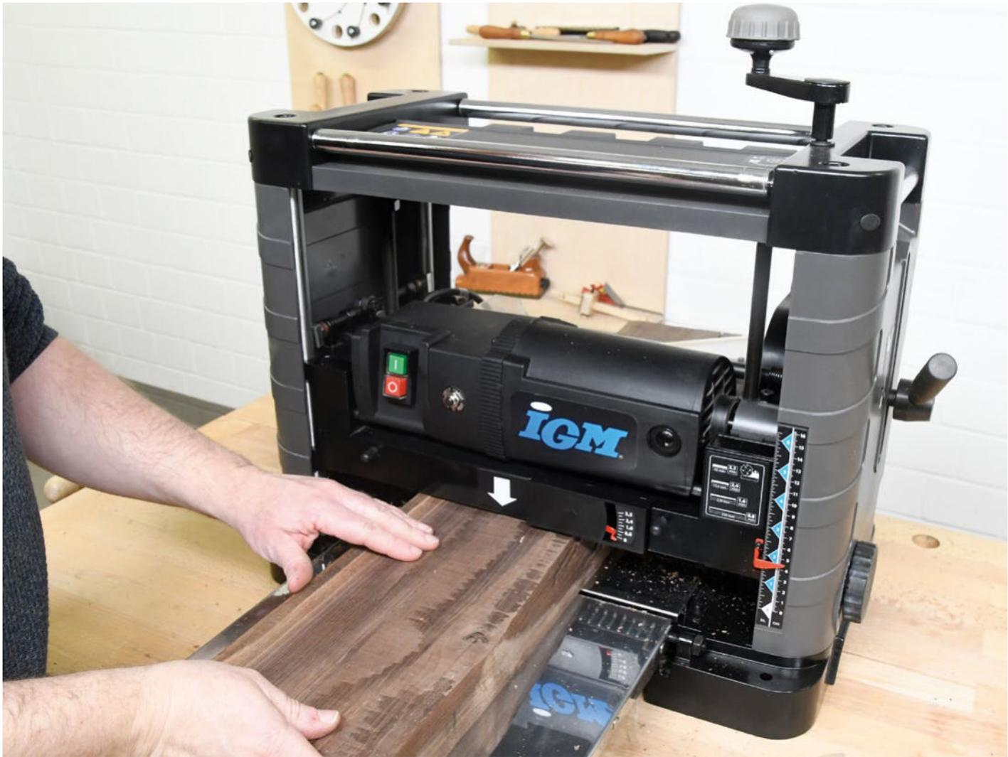
geschärft. Eine Scharte oder stumpfe Schneidkante kann also durch einfaches Drehen der Plättchen ausgemerzt werden – einer der Vorteile, die alle Spiralmesser-
