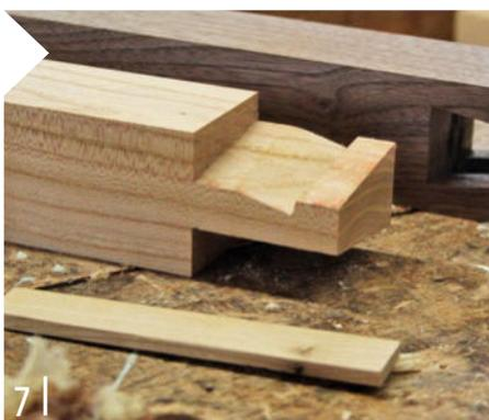
**1** Die Schräge des Zinkens lässt sich sehr gut mit einem Lineal anreißen, wenn man mit einem Streichmaß kleine Kerben in den Kanten des Holzes als Referenz gesetzt hat.
