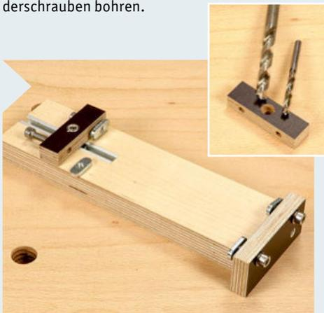
**15** | Die Befestigung des zweiten Gleitstreifens erfolgt über zwei verschiebbare Kopplungsstücke. Sie bekommen je zwei 6 mm Löcher in der Seite und oben ein 6 mm tiefes Sackloch ( $\emptyset$  11 - 12 mm) für den Schraubenkopf, anschließend ein 6 mm Durchgangslloch.
