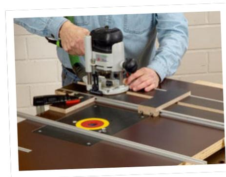
zum Nutenfräsen. Dafür werden die Gleitstreifen mit zwei Queranschlüssen, zwei Spannstreifen und einem Maschinenanschlag ergänzt. Zwischen die beiden stufenlos verstellbaren Gleitstreifen lassen sich dann Werkstücke bis zu einer Dicke von maximal 67 mm einlegen.
