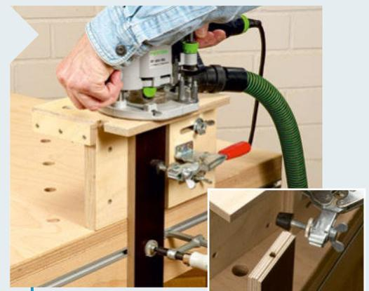
3 In das gefälzte Stirnende bohren Sie mittig ein 6-mm-Loch für die Zylinderschraube. Das muss exakt senkrecht verlaufen. Möglich ist das am Bohrständler oder mit einer Oberfräse und einem 6-mm-Nutfräser auf dem Multidübler (siehe Ausgabe 73).
