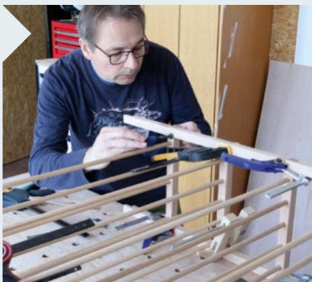
**12** | Nun werden die Schuhablagen mit den vier Beinen verleimt. Probieren Sie die Montage einmal ohne Leim, um den Bedarf an Zwingen zu ermitteln. Legen Sie Leim, Zwingen, Zulagen und einen feuchten Lappen zum Abwischen des überschüssigen Leims bereit.
