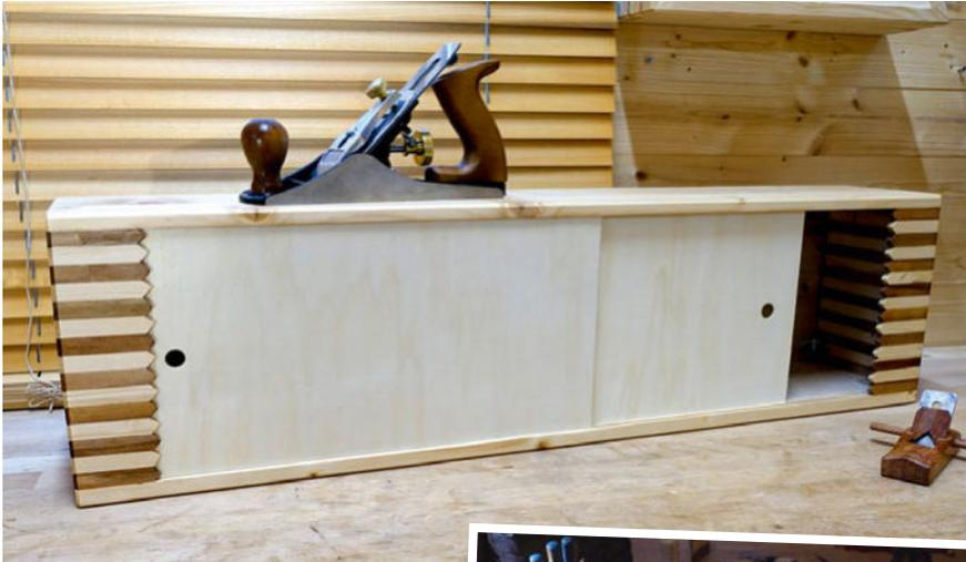
**Der Werkzeugschrank** (auf österreichisch „Werkzeugkasterl“) in Streifenoptik ist komplett aus Holzresten gefertigt. Die Schiebetüren bestehen aus Laubsägeholz. Akazie aus dem Baumarkt sorgt für den Farbkontrast zur Fichte. Der Schrank bietet Platz für ein Schleifgerät mit Zubehör und drei kleinere Handhobel. Die Größe des Möbels ist 88 x 25 x 14 cm. Für mich als Anfängerin war die Fertigungsdauer vielleicht etwas länger, aber
