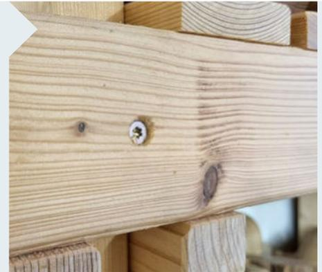
**6** Die fertigen beiden Säulenpaare mit den Querträgern stehen an den Außenseiten des Regals. Legen Sie die Traversen auf und fixieren Sie sie je mit einer Schraube gegen das Verrutschen. Die restlichen Säulenpaare in der Mitte werden im Anschluss integriert.
