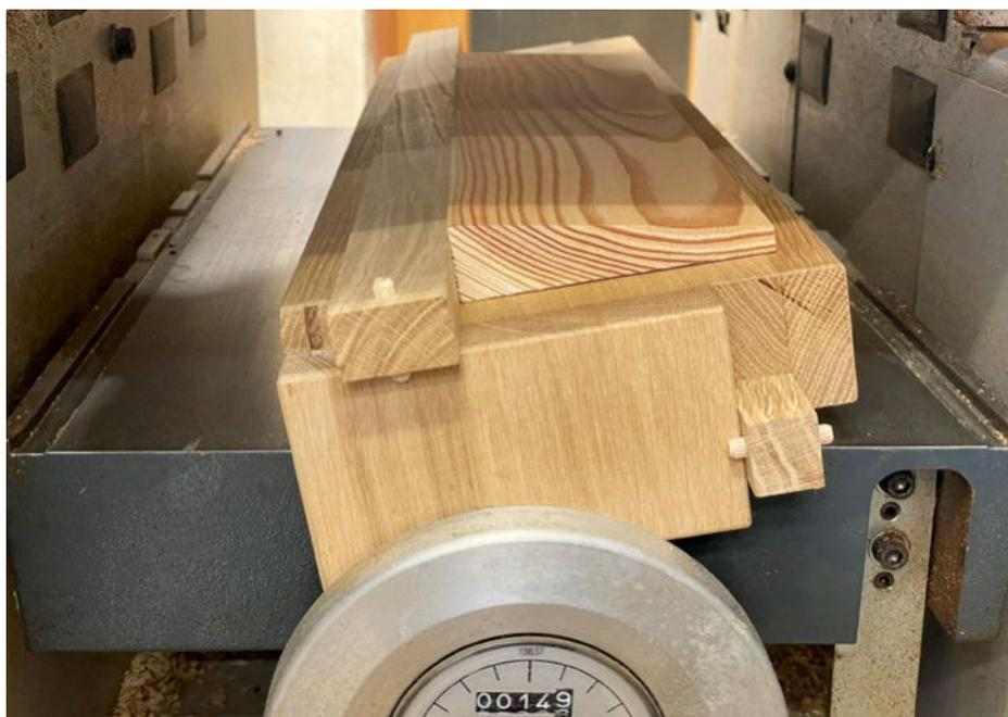
Die Einstell-Leisten (die Leisten mit Dübeln am Ende) haben zwei Funktionen: Unten rechts unter dem Trog liegend bestimmen sie den Winkel der Schräge am Werkstück. Obendrauf am Anschlag der linken Seitenleiste liegend verhindern sie, dass die Einzugswalze des Dickenhobels den Trog beschädigt.
