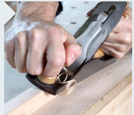
**2** Sind alle Riegel und Haken gesägt und geschliffen, fassen Sie nur die Kanten, die später nicht auf der Wand aufliegen. Hier hilft ein Handhobel hervorragend. Oberfräse oder Schleifklotz und Handschleifpapier sind aber auch möglich.
