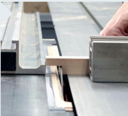
**8** Weiter geht es mit den Schuhregalen. Sind die Beine und der Querriegel (Pos. 1a, 1b & 2) zugeschnitten, kommen die Überblattungen an die Reihe. Beim Erstellen dieser und der Nuten hilft die Tischkreissäge. Feinarbeiten erledigt ein scharfes Stecheisen.
