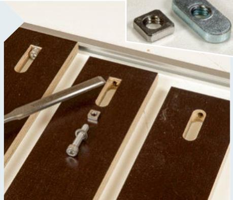
**5** Die vordere Rundung des Langlochs stechen Sie mit einem Stechbeitel rechteckig nach. Anschließend stecken Sie die Zylinderschraube samt Unterlegscheibe durch das Langloch in die 6-mm-Bohrung. Drehen Sie dann eine Vierkantmutter oder eine ovale Gleitmutter auf.
