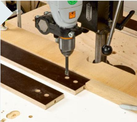
**4** Die gefälzten Enden bekommen anschließend ein Langloch für die Zylinderschraube. Dazu bohren Sie zuerst zwei 12-mm-Löcher auf dem Bohrständler und verbinden die Bohrungen mit der Stichsäge zu einem Langloch gemäß den Zeichnungen.
