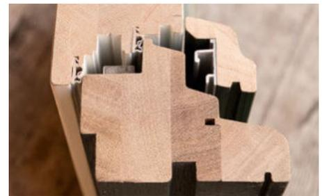
Moderne Fenster sind aus mehreren Kanten zusammengesetzt. Das garantiert Maßhaltigkeit. Die Nuten an der Unterseite der Wetterschenkel lassen das Wasser ablaufen.
