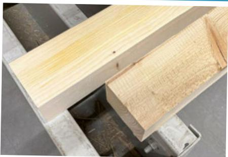
Konstruktionsvollholz (oben) und Rahmen- oder Kanthölzer (unten) lassen sich optisch oft leicht unterscheiden.
