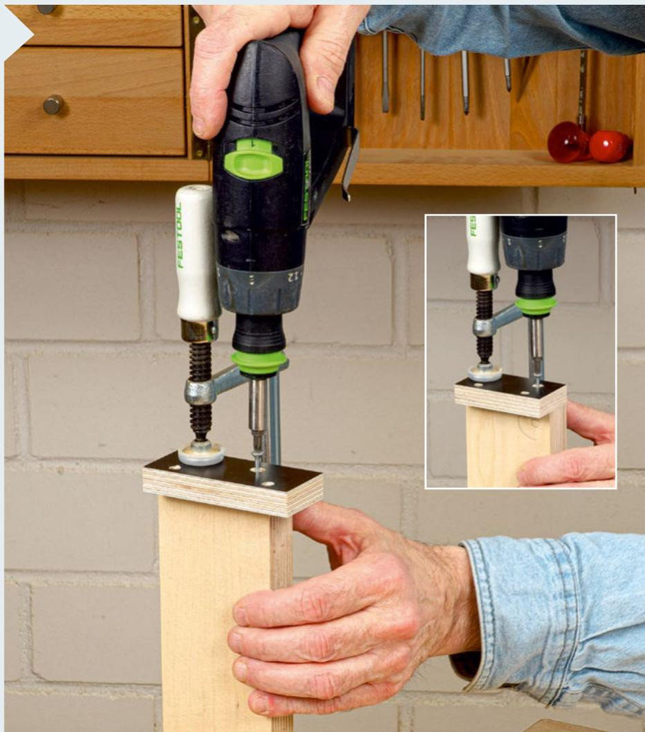
**14** | Die Kopplungsstücke befestigen Sie anschließend mit je zwei 3,5 x 35-mm-Schrauben am Stirnende der Queranschlänge. Wichtig: Das längere Kopplungsstück (Pos. 5) am vorderen Queranschlag steht dabei rechts um 19 mm über.
