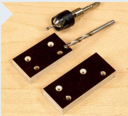
**13** | Um die beiden Kopplungsstücke (Pos. 5 und 6) an den Queranschlänge zu befestigen, bohren und senken Sie zuerst je zwei 3,5-mm-Löcher. Danach mit dem 6-mm-Bohrer noch je zwei weitere Durchgangslöcher für die M6-Zylinderschrauben bohren.
