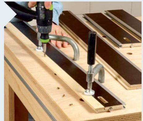
**9** Jetzt fehlen noch die auswechselbaren Splitterstreifen. Diese schrauben Sie einfach mit Spanplattenschrauben (3 x 12 mm) im Falz der langen Gleitstreifen fest. Am besten gleich ein paar Splitterstreifen mehr zuschneiden, so ist später schnell Ersatz da.
