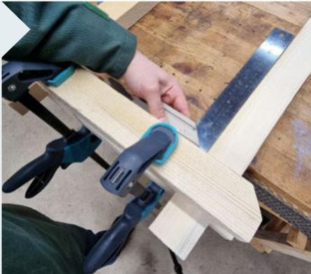
**4** Richten Sie je zwei Querträger exakt winklig zu den Säulen aus und achten Sie unbedingt darauf, dass beide Querträger auf einer Höhe sind. Zwingen Sie dann alles fest. Bereiten Sie zunächst nur zwei Säulenpaare mit je sechs Querträgern so vor.
