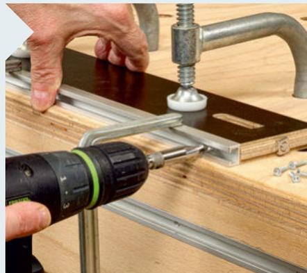
**8** Spannen Sie die 15 mm dicken Gleitstreifen flach auf die Werkbank und spannen Sie auch die 14 mm breiten T-Nuttschienen hochkant davor fest. Danach bohren Sie zuerst mit einem Zentrierbohrer die Löcher vor und schrauben anschließend die T-Nuttschiene fest.
