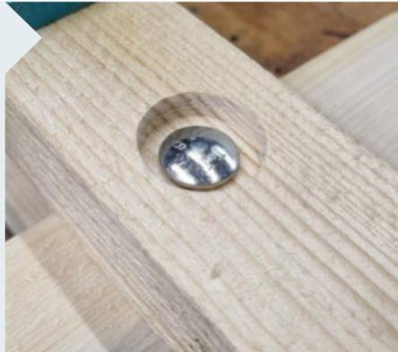
**5** Für die Schlossschraube muss eine 8-mm-Bohrung gesetzt werden. Um die Köpfe zu versenken, können Sie zuerst ein Sackloch mit einem Forstnerbohrer bohren. Ziehen Sie die Muttern auf der anderen Seite gut an.
