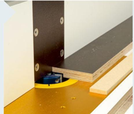
**6** Jeweils eine Längskante der beiden langen Gleitstreifen bekommt an der Unterseite noch einen 20 mm breiten und 6 mm hohen Falz passend zu den 6 mm dicken Splitterstreifen aus MDF. Wichtig: Langloch und Fräser sind beim Fräsen am Werkstückende!
