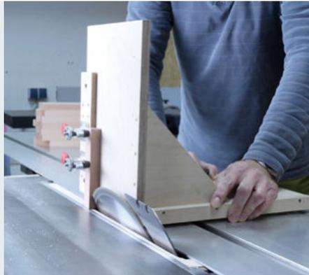
**4** Mit der Vorrichtung (siehe Kasten zu Beginn des Artikels) können Sie die Winkel (30° und 70°) der Garderobenhaken an der Kreissäge schneiden. Prüfen Sie vor dem Sägen, ob die Spanner das Werkstück sicher fixieren. Für das Foto wurde die Spanhaube entfernt.
