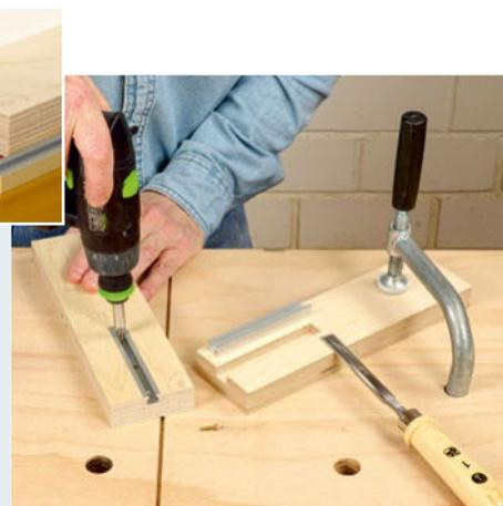
**11** | Als erstes fräsen Sie in die beiden Queranschlänge je eine 100 mm lange Nut (14 x 10 mm) für die T-Nutschiene. Das geht auch mit einem 10-mm-Nutfräser, indem Sie den Fräsanschlag nach dem ersten Frässchritt um 4 mm nach hinten verschieben.
