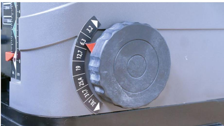
Idee gut, Umsetzung nervtötend: Ein Tiefenanschlag macht das schnelle Absenken auf die immer gleiche Hobeltiefe wiederholgenau möglich. Leider sind hier nur umgerechnete Zoll-Maße als ziemlich schräge Millimeter-Angaben fix wählbar.
