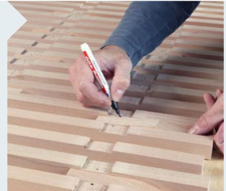
**5** Legen Sie die nummerierten Riegel mit der Rückseite nach oben auf die Werkbank. Markieren Sie mit einem gut sichtbaren Stift die Stellen, an denen die Haken montiert werden. Hier bohren Sie die Sacklöcher für die Splinte (Holzdübel) in den Haken ein.
