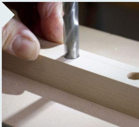
**9** In die Querriegel (Pos. 2) werden nach Maßvorgaben (siehe Zeichnung) die Sacklöcher für die Rundstäbe gebohrt. Begrenzen Sie den Bohrer in der Tiefe, sodass Sie nicht durchbohren und die Abstände zwischen den Riegeln stimmen.
