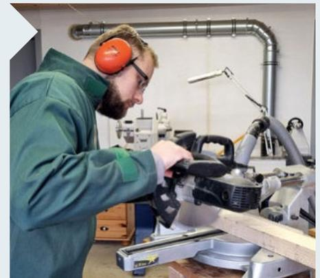
**2** Eine Kappsäge ist die ideale Maschine, um alle Elemente abzulängen. Wer von Hand sägt, sollte auf gerade Schnitte achten.
