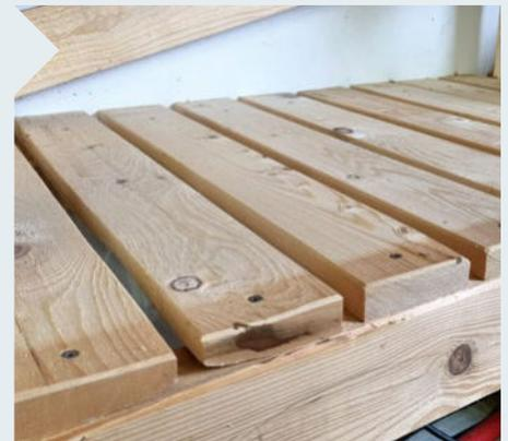
**8** Die Regalböden können angebracht werden. In meinem Fall hatte ich noch viel von den 20 x 70-mm-Latten eines anderen Projekts übrig. Dies verbessert die Belüftung der Rohlinge. OSB-Platten sind wesentlich schneller angebracht.
