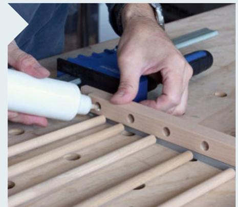
**10** Die Querriegel und die Rundstäbe sind fertig: Schon werden sie zu Schuhablagen verbunden. Ein klassischer Holzleim (D3) reicht hier völlig aus. Setzen Sie Zwingen an, prüfen Sie die Parallelität der Riegel und lassen Sie alles über Nacht abbinden.
