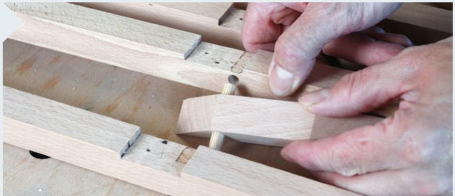
**7** Legen Sie die Riegel (Pos. 14 & 15) in der korrekten Reihenfolge auf die Werkbank. Stecken Sie die mit Rundstäben (Pos. 1) versehenen Haken (Pos. 16) in die passenden Löcher. Verschrauben Sie die Riegel mit den Brettern (Pos. 17) von hinten, ist dieser Teil fertig.
