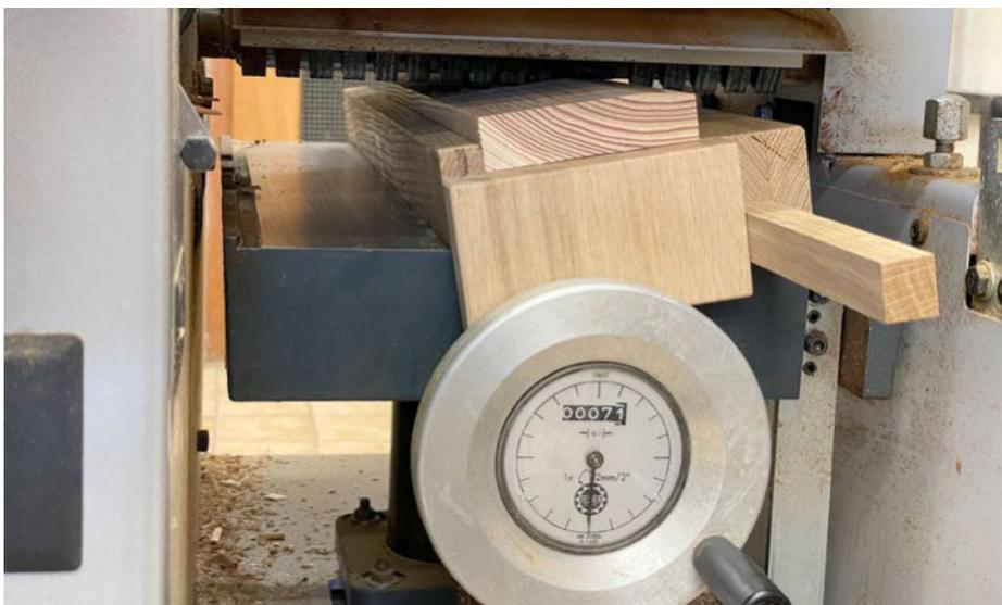
Bei kleineren Schrägen ist die obere Einstell-Leiste nicht nötig. Das Werkstück kann einfach an der Seitenleiste entlanglaufen.
