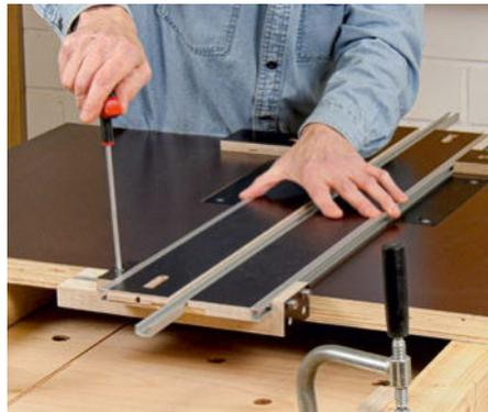
Passgenaues Einnuten von T-Nuttschienen ohne Messen: Die Schiene zwischen die Gleitstreifen legen, Vorrichtung in der gewünschten Position festzwingen und schrittweise die Nut einfräsen.
