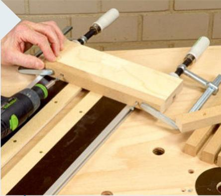
**16** | Zum Ausrichten der Vorrichtung und als Splitterschutz schrauben Sie an den vorderen Queranschlag noch eine Splitterleiste aus 19 mm dickem MDF. Da man diese Leiste auch schon mal auswechseln muss, lohnt es sich, auch hier gleich wieder ein paar mehr herzustellen.
