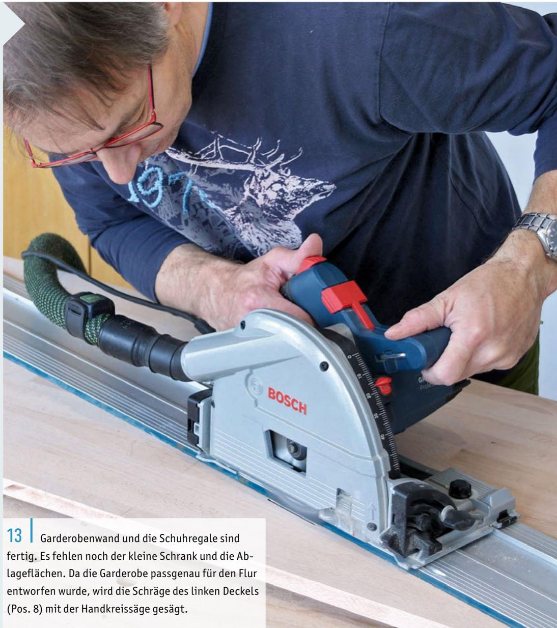
**13** | Garderobenwand und die Schuhregale sind fertig. Es fehlen noch der kleine Schrank und die Ablageflächen. Da die Garderobe passgenau für den Flur entworfen wurde, wird die Schräge des linken Deckels (Pos. 8) mit der Handkreissäge gesägt.
