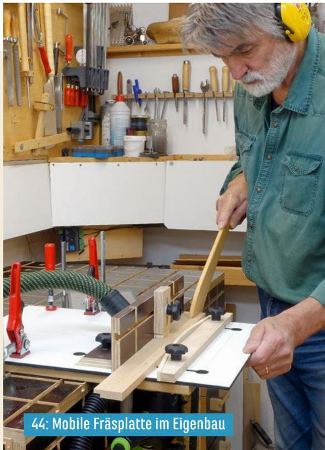
44: Mobile Fräsplatte im Eigenbau
