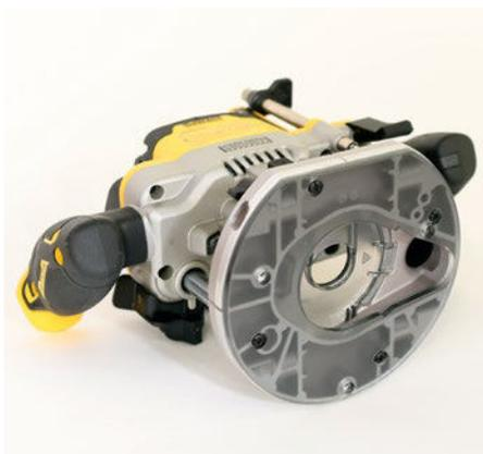
Die Tropfen-Form unter der Maschine sorgt in Kombination mit einer der beiden Abdeckungen dafür, dass Späne durch die Drehbewegung des Fräsers Richtung Absaugung geschleudert werden.
