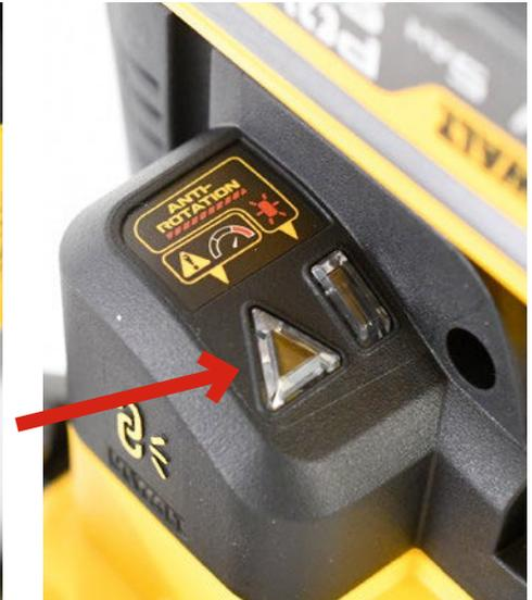
Via einer Warn-LED (Pfeil) meldet sich die Elektronik, wenn die Maschine zu viel Strom aus dem Akku ziehen muss, um die Drehzahl konstant zu halten. Das schont Batterie und Maschine.
