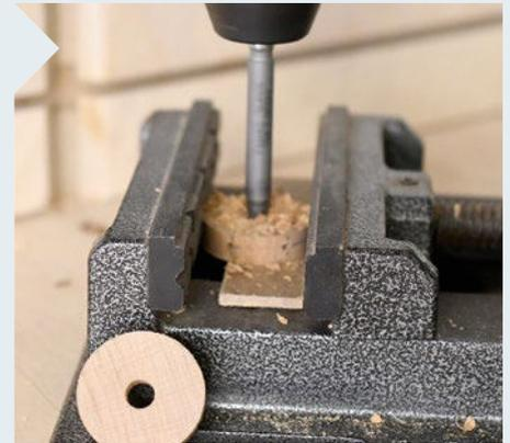
**8** Bohren Sie in die Scheiben mit den kleinen Löchern ein 10-mm-Loch, in die ohne ein 8-mm-Loch. Bei dünneren Rundstäben kann Klebeband ein Reißen der Scheiben verhindern.
