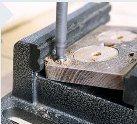
**15** Spannen Sie die Kasette noch einmal in einem Winkel von etwa 15° ein und bohren Sie auf der Rückseite zwei schräge 10-mm-Löcher zum Aufhängen. Hier finden später Nagelköpfe, die in der Wand stecken, ihren Platz.
