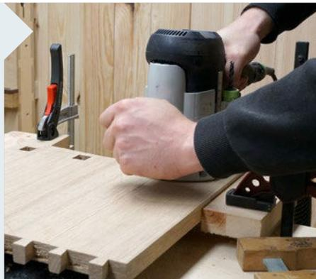
**22** | Der Ausschnitt für die Füße wird mit der Stichsäge grob vorbereitet, die Oberfräse mit einem vom Schaft aus oben liegenden Fräser mit Anlaufring gerüstet. Nun kann die zuvor aufgeschraubte Kontur nachgefahren werden.
