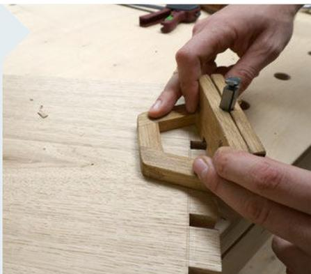
**9** | Mit etwas Übung kann der Grund der Zinken zwar auch mit dem Stecheisen ausgearbeitet werden, der wiederholgenaue Grundhobel macht bei dieser Arbeit aber einfach zu viel Spaß.
