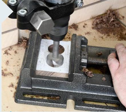
**5** Bohren Sie auf der Rückseite mit einem 35-mm-Forstnerbohrer 10 mm tief ein. Anschließend bohren Sie von vorne mit einem 10-mm-Bohrer durch.
