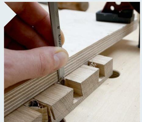
**6** Scharfe Eisen sind Pflicht bei der Ausarbeitung der Zinken am Deckel. Da kaum noch Material entfernt werden muss, kann man die gewonnene Zeit für mehr Konzentration nutzen.
