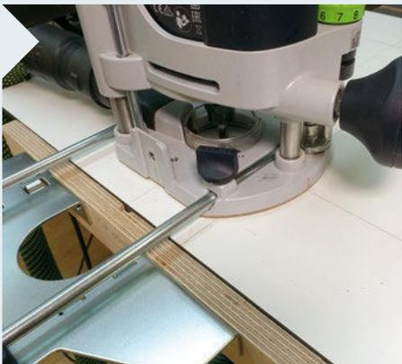
**7** Zeichnen Sie Positionen und Längen der 8-mm-Schlitzte für die Schlossschrauben auf der Unterseite der Frästischplatte an und richten Sie die Oberfräse daran aus. Achten Sie dabei darauf, dass Ihnen später die Gardinenwinkel nicht in den Weg kommen.
