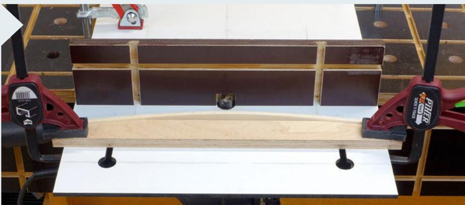
**10** Der Grundkörper der Andruckfeder erhält noch zwei 8-mm-Bohrungen. Spannen Sie ihn auf die Platte auf und markieren Sie die Bohrposition von unten anhand der eingefrästen Schlitzte.
