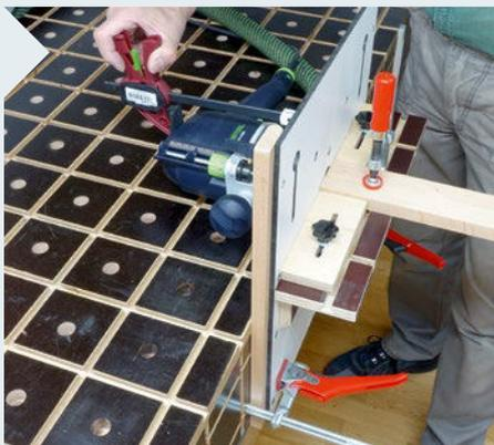
**15** | Eine senkrechte Montage des Frästisches schafft eine horizontale Fräposition. So sind Bohrungen an Stirnholzflächen zum Beispiel mittels Spiralnutfräsern möglich. Zwei Anschlagklötze am Fräanschlag sorgen für wiederholgenaues Positionieren.
