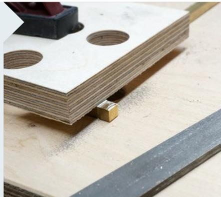
**23** | Um die vierkantigen Messingstäbe rechtwinklig beidseitig abzufilen, wird erneut ein Anschlag aus Multiplex verwendet. Im Gegensatz zur Holzbearbeitung dauert der Materialabtrag ein paar Minuten länger.
