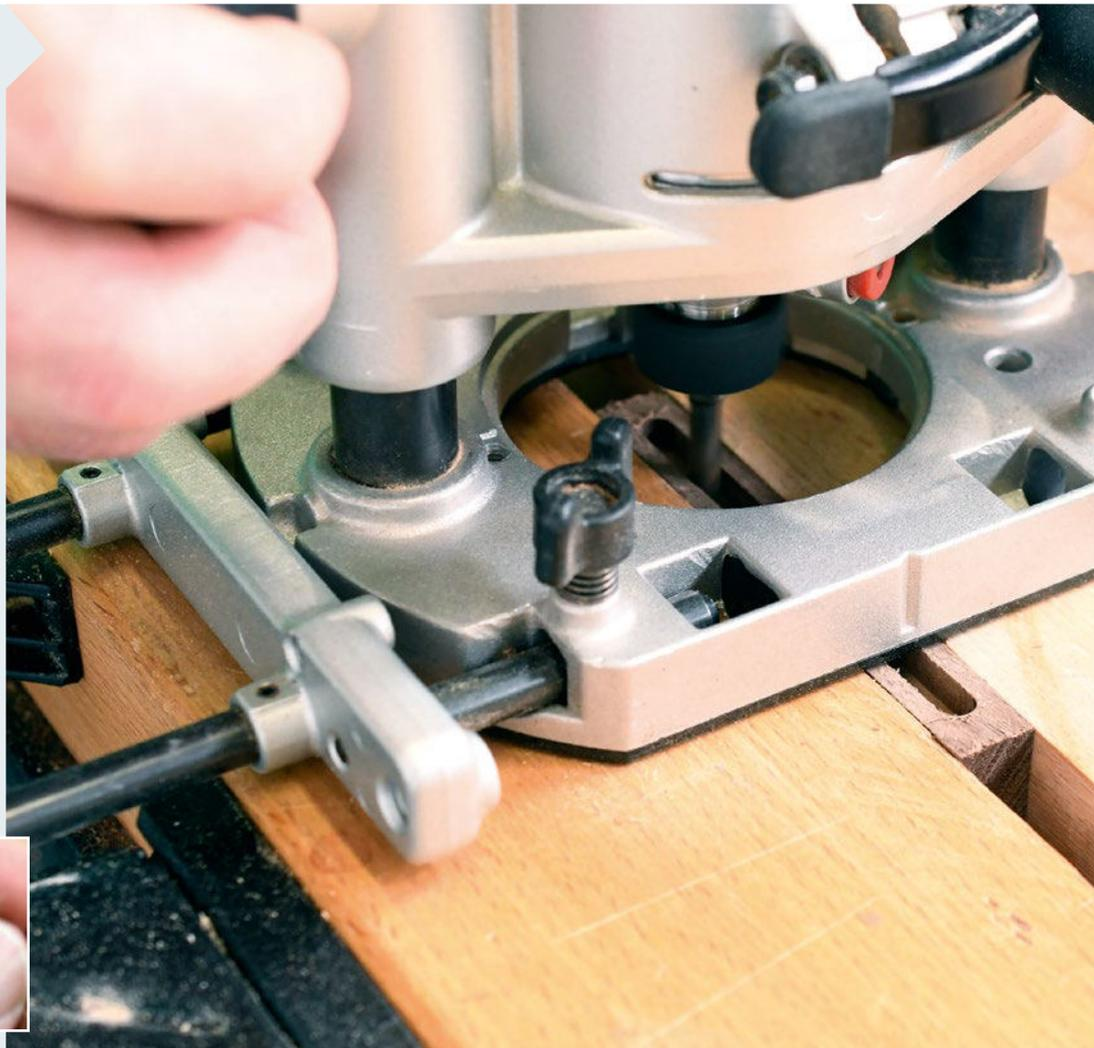
**3** Der Grundkörper der Kassette – ein simples Rechteck – bekommt unten mittig eine 8-mm-Nut (5 mm tief), die jeweils 10 mm von der Kante endet. Die Fräse mit dem Parallelanschlag an der Hobelbank entlangzuführen ist einfacher, als so ein kleines Teil am Frästisch zu bearbeiten.
