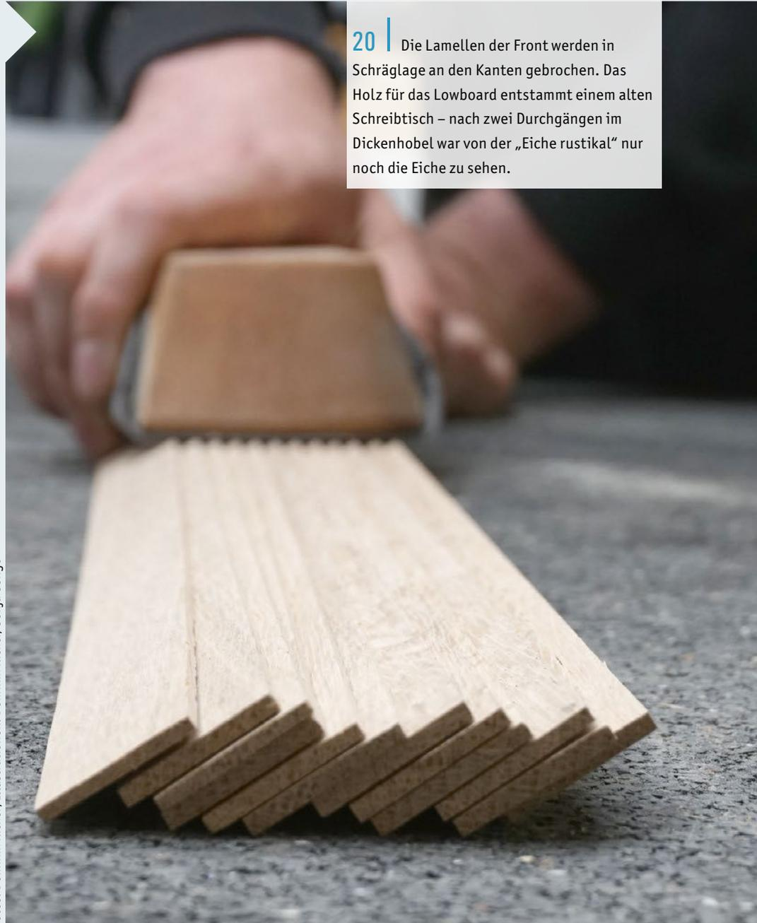
**20** | Die Lamellen der Front werden in Schräglage an den Kanten gebrochen. Das Holz für das Lowboard entstammt einem alten Schreibtisch – nach zwei Durchgängen im Dickenhobel war von der „Eiche rustikal“ nur noch die Eiche zu sehen.
