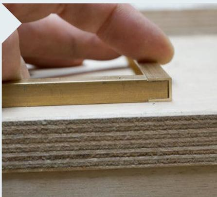
**24** | Vierkantstab und U-Profil für den Rahmen passen nun zusammen. Die Lücke ermöglicht ein Quellen und Schwinden des Quermessings... Nein. Sie zeigt, dass das Arbeiten mit ungewohnten Werkstoffen Übung braucht. An dieser Stelle ist „Mut zur Lücke“ in Ordnung.
