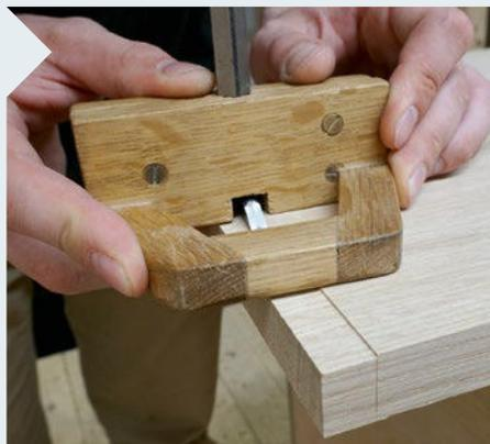
**13** | Grundhobel oder Oberfräse mit Anschlag können zum Absetzen des Falzes verwendet werden. Mit dem Grundhobel kann dagegen ohne Vorrichtung losgelegt werden. Das langsamere Arbeitstempo minimiert die Wahrscheinlichkeit, über den Riss hinaus zu hobeln.
