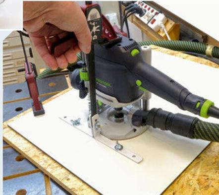
**5** Der Druckpunkt des Zwingenkopfes trifft jetzt genau auf die Mitte des Gehäuses der OF 1010 R. Ist alles fixiert, können Sie mit einem stirnschneidenden Nutfräser das Durchgangs-loch von unten durch die Platte fräsen.
