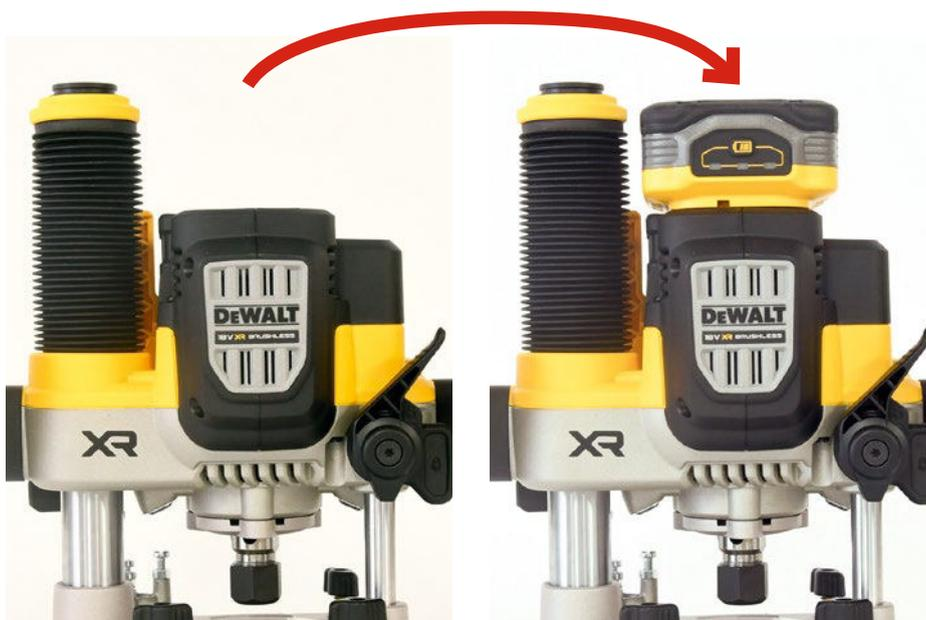
Kopflastig: Wie bei allen Akku-Fräsen ist auch bei der DCW620 der Akku oben auf der Maschine. Durch die kompakte Bauform (ohne Akku etwa 25 cm, mit etwa 29 cm (jeweils ohne Absaugstutzen) der Fräse fällt die asymmetrische Gewichtsverteilung hier aber weniger auf.
