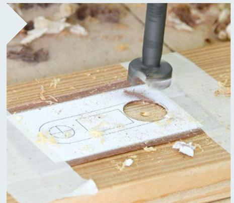
**11** Das Inlay besteht aus (Kunst-)Mahagoni. Schneiden Sie es mithilfe der Schablone zu. Für die Rundung der inneren Aussparung hilft ein sehr scharfer 18-mm-Forstnerbohrer. Befestigen Sie dafür das Furnier mit einem Klebestift und Klebeband auf einem Opferbrett.
