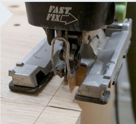
**19** | Mit etwas Abstand zum Riss kann die Stichsäge zur Herstellung der Zapfen sehr dienlich sein. Die Nachbearbeitung findet wieder mit dem Stecheisen statt, je breiter, desto besser in diesem Fall.
