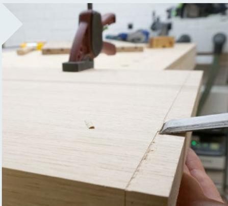
**12** | Bei Arbeiten im Querholz sollte man stets an Ausrisse denken und wie diese sich vermeiden lassen. Kräftiges Anreißen mit dem Streichmaß durchtrennt die Fasern an der Wange. Ein leichtes Absetzen mit dem Stecheisen erleichtert die Arbeit mit dem Grundhobel.
