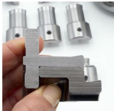
Seitlicher Blick auf die ausgebauten Backen: Die Spezialbacken (unten, dunkel) liegen – zusätzlich zur Verschraubung – formschlüssig in den Standardbacken.
