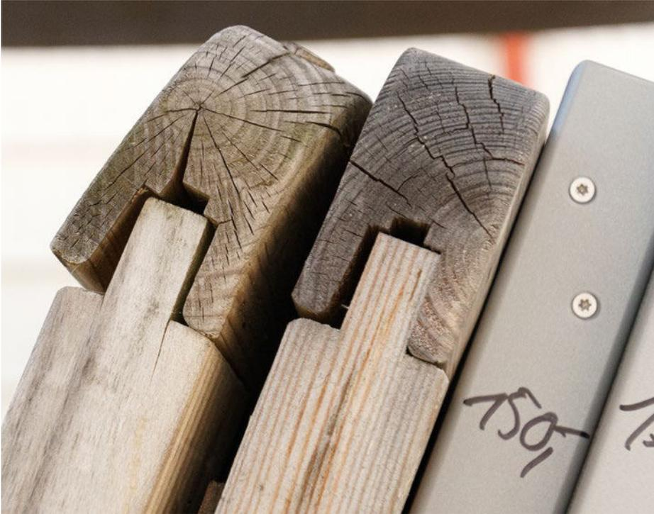
Wenn der Kern mitverarbeitet wird, reißen solche Riegel sofort. Diese Holzauswahl ist für den Außenbereich ungeeignet!
