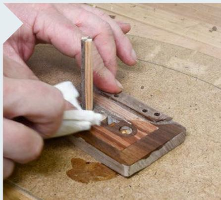
**16** Sägen Sie den verleimten „Stift“ auf die richtige Länge. Schleifen Sie 10 mm der Längskanten rund. So können Sie ihn in das 8-mm-Loch ohne die Zacken kleben. Schleifen Sie eine kleine Vertiefung für den Schlüsselring ein. Ölen Sie alles – außer der unteren Nut.
