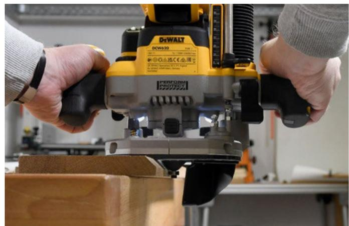
An Kanten bugsiert der mitgelieferte Spanfang viel Dreck Richtung Absaugung. Massive Abplattungen oder Schweizer Kanten fräst die Maschine zügig, das Balancieren auf schmalen Kanten ist aber schwierig.
