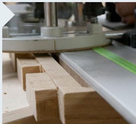
**26** | Die Nut für die Messingprofile in der Front fräst die Oberfräse an der Führungsschiene ohne Kopierring. Der Anlaufring des Fräasers wird an den Splitterschutz der Schiene herangeführt, sodass nach Riss gefräst werden kann.
