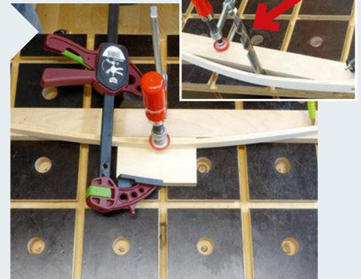
**9** Spannen Sie die Leiste für die Andruck-feder auf einen Grundkörper und markieren Sie den Bogen. Sägen Sie den Grundkörper entspre-chend aus. Legen Sie mittig einen 13-mm-Boh-rer unter (Pfeil), wenn Sie die Leiste dann mit je drei Schrauben (3 x 20 mm) befestigen.
