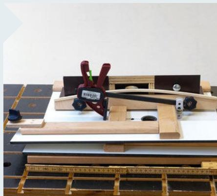
**16** | Bei Nichtgebrauch macht sich der Frästisch klein: Die Zwinne kann nach dem Entfernen der M6-Schraube im Langloch einfach umgeklappt werden. Alle Zubehörteile liegen auf der Frästischplatte. Ein aufgeklebter Magnet hält die Befestigungsschrauben.
