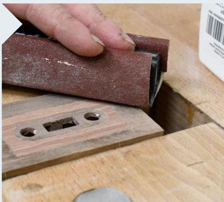
**13** Jetzt können Sie die Reste der Schablone entfernen und alles plan schleifen.
