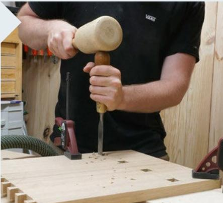
**18** | Bei Stemmarbeiten sollte das Werkstück stets gut fixiert werden. Eine Werkbank mit Lochraster ist schnell hergestellt. Auch eine Sparversion mit ein paar gut platzierten Bohrungen erleichtert das Spannen enorm.
