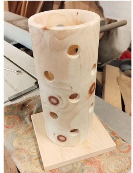
**User Josef Konrad** hat aus einem etwa 35 Zentimeter langem Zirbenholzstück einen Zirbenlüfter gedreht. Dabei hat er zunächst das Zirbenstück auf etwa 13 bis 14 Zentimeter Durchmesser zylindrisch gedreht. Löcher einteilen und bohren waren die folgenden Schritte. Danach hat er das Zirbenholz innen ausgebohrt und bis auf eine Wandstärke von etwa 15 Millimetern ausgedreht. Der Lüfter ist auf einer Bodenplatte montiert und wurde abschließend mit Zirbenspänen gefüllt.
