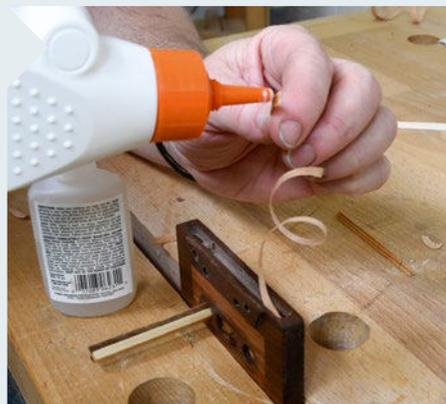
**17** Für den „Bandsalat“ brauchen Sie einen etwa 6 mm breiten, relativ dicken Hobelspan. Kleben Sie ihn mit etwas Sekundenkleber oder schnell bindendem Leim in die Nut.
