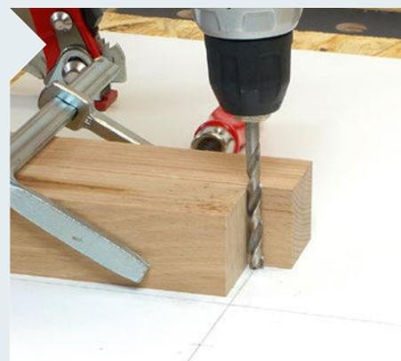
2 Ein Kreuz auf der Unterseite der Frästischplatte markiert den späteren Durchgangsloch-Mittelpunkt und ist Referenz für weitere Bohrpositionen. Ohne Bohrschablone gelingt senkrecht Bohren hier mittels zwei versetzt angeordneter Kanthölzer.
