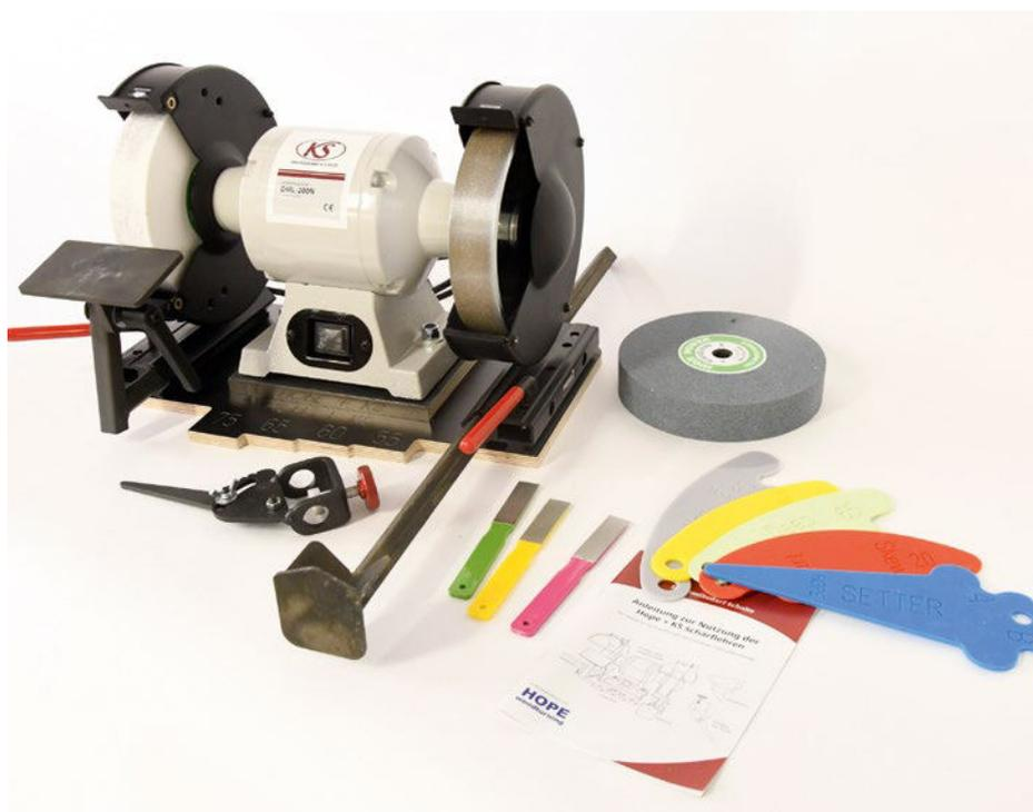
Das volle Programm des Sets: Schleifer, Wolverine-Schleifhilfen, (hier bereits montierte) CBN-Scheibe, Einstellhilfen, Diamantfeilen. Mehr braucht nicht, um alle gängigen Eisen zu schärfen.
