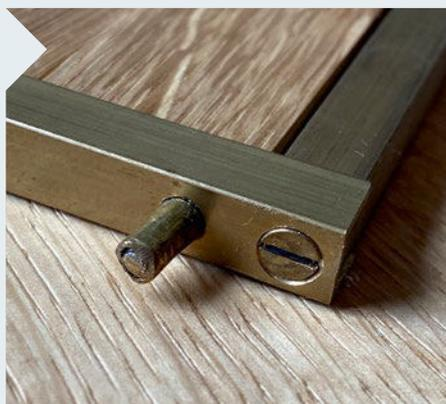
**28** | Die Führungstifte (zwei je Seite) bestehen aus einer metrischen Schraube, die von hinten in das U-Profil geschraubt wird, und einer eingeklebten Messinghülse. Letztere sollte sich nach ein paar Zügen mit der Feile gut im führenden U-Profil bewegen lassen.
