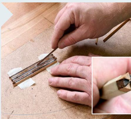
**2** Längen Sie die Dreieckleisten auf etwa 10 cm Länge zu. Verleimen Sie dann sechs davon zu einem Sechseck. Klebeband ist hier ideal, um die Leisten eng an eng zu positionieren. Wickeln Sie das Paket dann stramm mit dem Klebeband zusammen.
