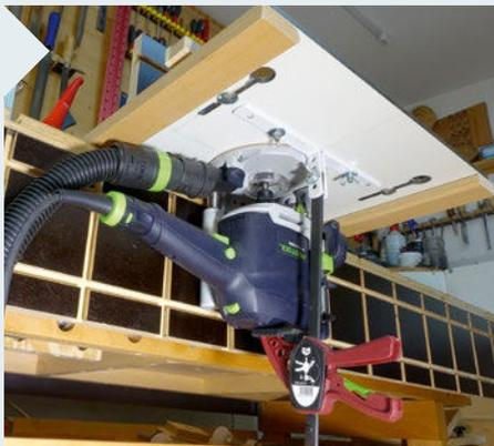
**13** | Ein Blick unter den Tisch: Schalter und unterer Absauganschluss sowie die Höhenklemmung und der Tiefenanschlag sind bei der OF 1010 R gut zugänglich. Auch der Fräserwechsel ist leicht möglich.
