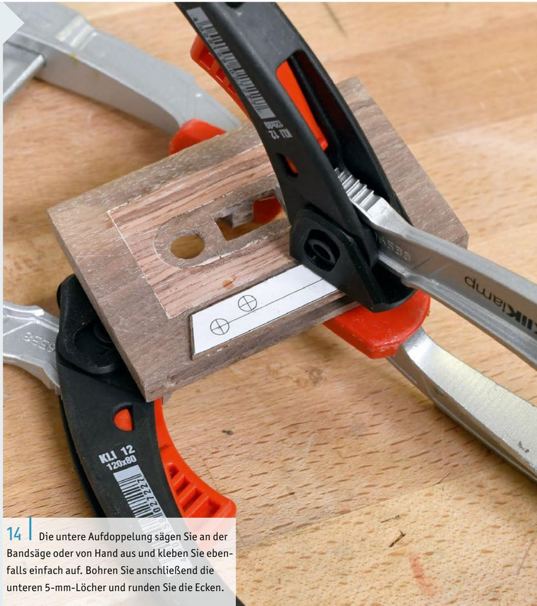
**14** Die untere Aufdoppelung sägen Sie an der Bandsäge oder von Hand aus und kleben Sie ebenfalls einfach auf. Bohren Sie anschließend die unteren 5-mm-Löcher und runden Sie die Ecken.
