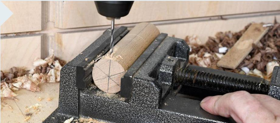
**7** Bohren Sie nun mit einem 2,5-mm-Bohrer senkrecht in den Rundstab, jeweils 13 mm tief. Anschließend sägen Sie zwei 10 mm starke Scheiben vom Rundstab ab; eine mit den kleinen Löchern, eine ohne.
