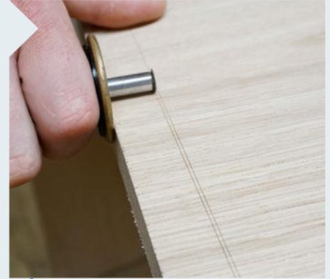
**1** Der rechtwinklige Zuschnitt ist das Fundament vieler Projekte. Der selbstgebaute Anschlag wird vor der Verwendung mit einem möglichst großen Winkel überprüft. Als rutschfeste Unterlage und Schnitenschutz dient eine Gummimatte.
