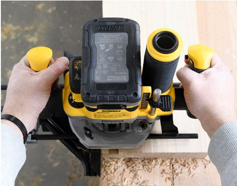
Die Hände liegen fest und leicht nach schräg vorne auf den Griffen. Das ist für eine Oberfräse erst einmal ungewohnt. Die vorteilhafte Ergonomie dieser sehr sicheren Halteposition wird aber nach wenigen Minuten Arbeit spürbar.
