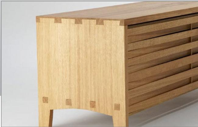
Bevor sich das Projekt nun weiter in der Präzision verliert, erledigt zunächst die Oberfräse die grobe Vorarbeit: Sie räumt schnell die halbverdeckten Zinken aus. Bitte beachten Sie, dass die im Foto gezeigten Zinken in der Zeichnung angepasst wurden. In der Zeichnung sind sie mit sechs Schwalben optisch besser verteilt.
