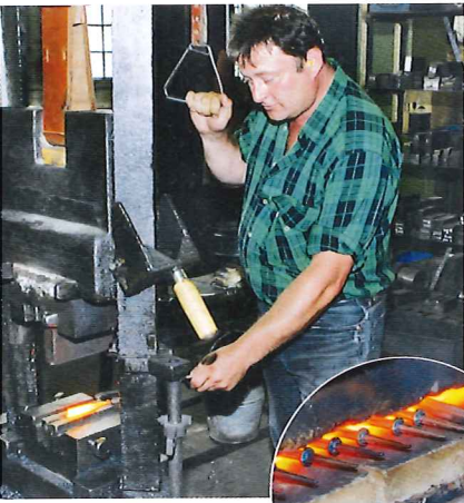
An kleineren Hämmern und Stanzen werden Spezialwerkzeuge wie Schnitzseisen weiter aus-geschmiedet.
