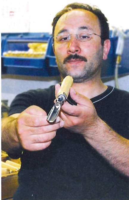
Die exakte Ausrichtung des frisch aufgedrückten Hefts aus Weißbuche wird an jedem Exemplar überprüft.
