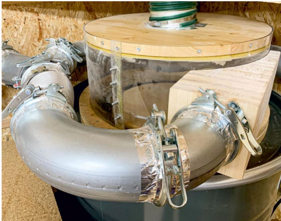
Erste Filterstufe der LVHP-Absaugung: Staub und Späne werden durch das Rohrsystem angesaugt und münden in eine nach seinem Erfinder J. Phil Thien „Thien Baffle“ benannte flache Variante des Zyklonprinzips. Das Absauggut fällt zu über 99 Prozent in die große Tonne. Der Rest wird nach oben in die zweite und dritte Filterstufe transportiert.
