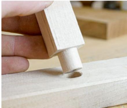
Das passende Zapfenloch wird mit dem Forstnerbohrer hergestellt. Sollte der Zapfen zu fest sitzen, kann das Werkstück wieder eingespannt und nachgedrechselt werden.
