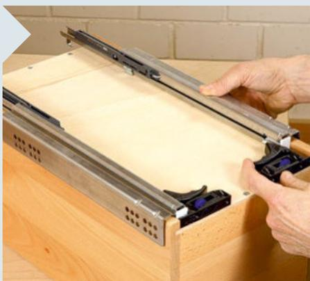
**14** | Für einen ersten Test können Sie jetzt die beiden Auszugschienen auf den Boden auflegen und in die Kupplungen hineinziehen. Der hintere Aufsteckhaken (C-Haken) sollte dabei in das Loch im Rückstück eingreifen.
