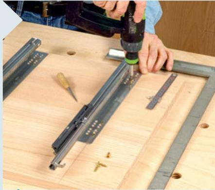
**5** Montieren Sie die Schubkastenvollauszüge (siehe Zeichnungen). Zum Verleimen und für die Oberflächenbehandlung werden sie wieder entfernt. Fasen Sie die Kanten der Seiten-, Deckel- und Bodenplatten per 45°-Fasefräser (Schneidenhöhe 16 mm) am Frästisch.
