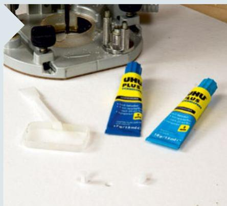
**30** Das 5-mm-Sackloch für die Kunststoffmuffe können Sie mit einem normalen HSS-Bohrer oder der Oberfräse herstellen. Die Muffe kleben Sie anschließend mit einem Epoxidharz-Kleber in das Loch. Dort hält später jede handelsübliche Spanplattenschraube.
