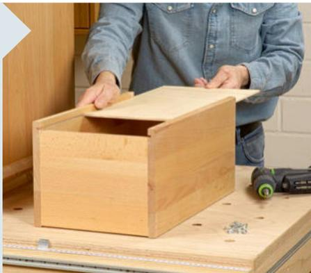
**11** | Die 5 mm dicken Sperrholzböden werden genau passend (ohne Luft!) zugeschnitten und nach dem Einschieben am Vorder- und Rückstück mit Rückwandschrauben (3 x 20 mm) befestigt.
