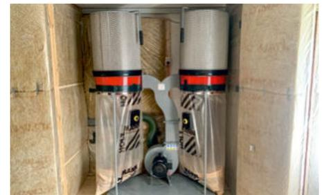
Entstauber mit Spänesäcken und Kartuschenfiltern in einer Schallschutzkabine: Diese Lösung schützt vor Lärm und kommt mit großen Späne-mengen klar.
