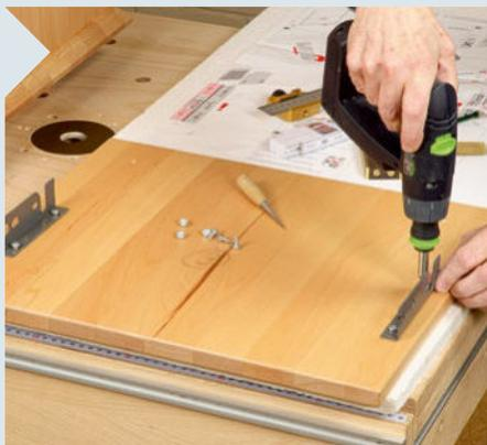
**21** Zu den Blenden und Rollen: Starten Sie mit der Montage der beiden unteren Blenden. Dazu markieren Sie die Schraubpositionen der beiden Blendenwinkel. Fixieren Sie die Winkel zunächst nur mit je zwei Schrauben in den Langlöchern.
