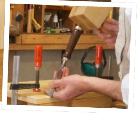
Die ganze Fläche lässt sich durch gleichmäßige Hiebe mit dem Stecheisen in immer gleicher Tiefe auflösen. Die durchtrennten Fasern lassen sich gut waagrecht mit einem breiten Stecheisen herausnehmen.
