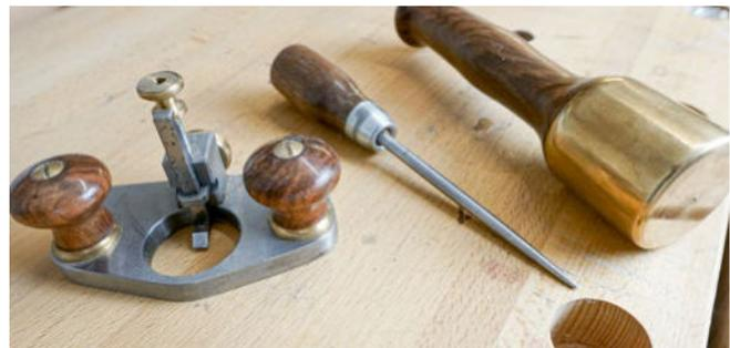
Der Hammer aus Messing ist vollständig an der Drechselbank entstanden. Wer mag, kann auch Werkzeugen von der Stange mit einem selbstgedrechselten Heft eine individuelle Note verleihen.
