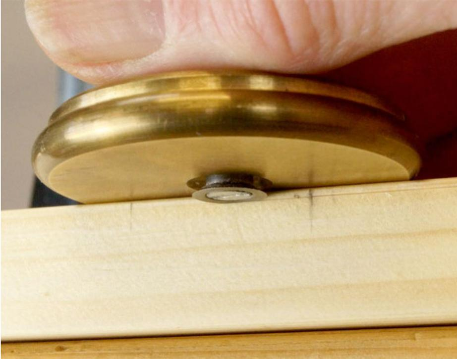
Reißen Sie den Grund der Lappentasche mit dem Streichmaß exakt an. Anders als ein Bleistiftstrich dient der Schnitt oder die entstandene Kerbe als Führung für das Stecheisen beim waagerechten und geraden Ausarbeiten der Vertiefung.
