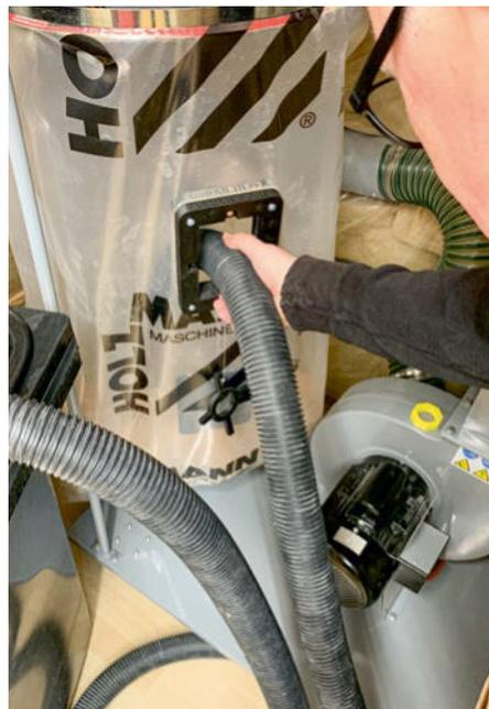
Einen Spänesack in die Mülltonne entleeren verursacht viel Staub. Eine clevere Lösung: Direkt aus dem Sack in die Mülltonne absaugen – mit einem passenden Staubsaugeraufsatz.
