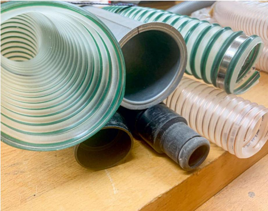
Verschiedene Absaugschläuche und Rohre: Der passende Durchmesser und die richtige Kombination sind entscheidend, um den Strömungswiderstand zu minimieren. Wichtig: Schläuche und Rohre müssen zur Technik des Absauggeräts passen, um maximale Effizienz und saubere Luft in der Werkstatt zu gewährleisten.
