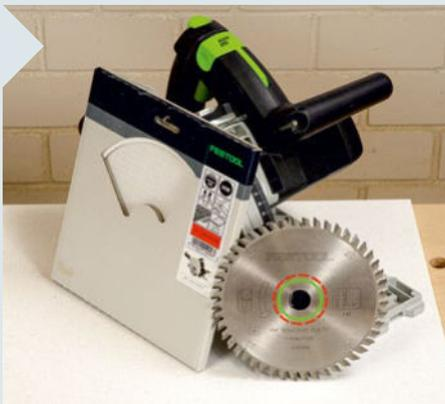
**26** Platten aus Mineralwerkstoff (etwa Corian oder Varicor) lassen sich genauso zuschneiden wie Holzplatten. Für besonders saubere und riefenfreie Schnittkanten ist jedoch ein Trapez-Flachzahnsägeblatt mit 48 Zähnen zu empfehlen.
