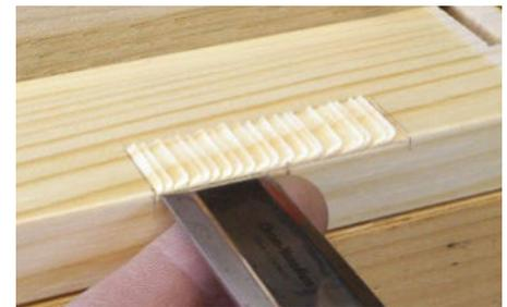
Setzen Sie das schräg gestellte Stecheisen immer nur wenige Millimeter weiter. Gleichmäßige Schläge führen zu Kerben mit gleicher Tiefe über die ganze Breite. Ein breites Stecheisen räumt dann von der Seite einfach das Material aus.
