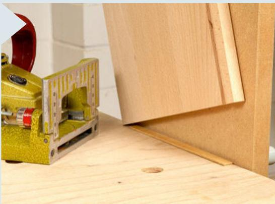
**9** Fixieren Sie die Seitenteile hochkant an einer Stützplatte. Fräsen Sie die Flachdübelschlitzte ein. Damit die Schlitzte mittig sitzen, legen Sie ein 2-mm-Sperrholz unter die Kante. Auch unter die Vorder- und Rückstücke müssen Sie dieselbe Stärke legen.
