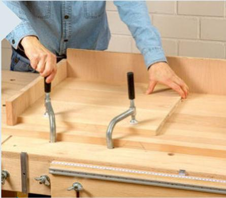
**4** Stecken Sie die Seitenwände und die Rückwand (oder wie hier Abschnitte davon) in die Bodenplatte. Fixieren Sie den breiten Zwischenboden dicht an Seiten- und Rückwand und nutzen Sie die Bodenkante zum Anlegen der senkrecht gestellten Flachdübelfräse.
