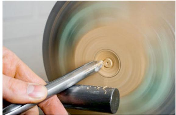
Mit dem Bleistift wurde im laufenden Betrieb der gewünschte Durchmesser angezeichnet. Mit etwas Fingerspitzengefühl wird nun die konkave Form ausgearbeitet.
