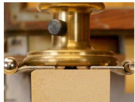
Das Einstellen eines Streichmaßes auf die Dicke des Bandlappens funktioniert am einfachsten, indem es mit der Andruckfläche auf zwei flach aufliegende Lappen gestellt wird. Das gelöste Schneidrad fällt von allein in die richtige Position.
