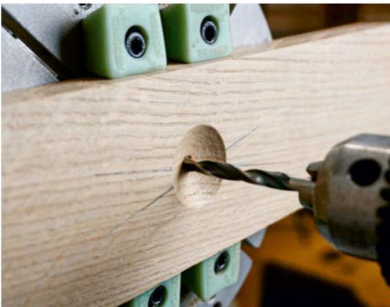
Beim Bohren unbedingt daran denken, die Drehzahl anzupassen, sonst fängt es schnell an zu rauchen. Vor allem wenn mit größeren Forstnerbohrern gearbeitet wird, sollte man bedenken: Großer Durchmesser – kleine Drehzahl und umgekehrt.
