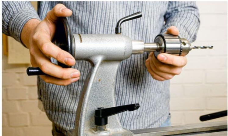
Das Bohrfutter wird in den Morsekonus eingesetzt und klemmt sich durch seine konisch zulaufende Form fest. Hier im Reitstock ist es die gleiche MK2-Konusform wie im Reitstock auf der Motorseite.
