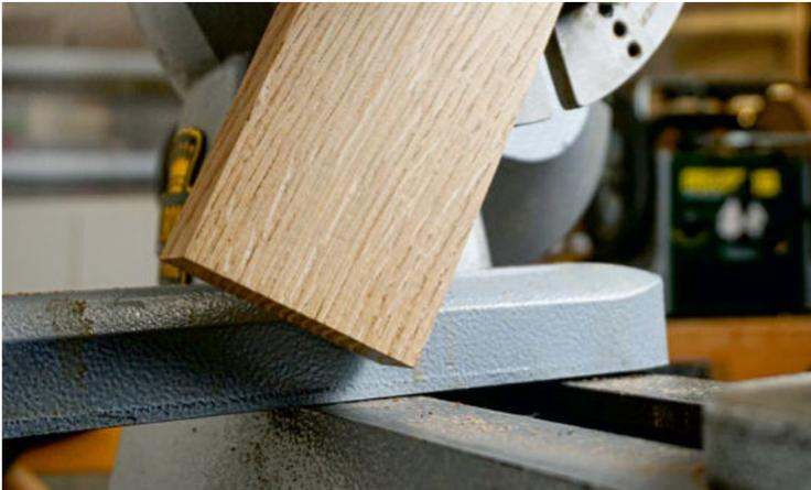
Ein offensichtlicher Fehler, der jedoch immer wieder passiert: Vor dem Einschalten der Maschine unbedingt einmal per Hand durchdrehen und überprüfen, ob das Werkstück auch wirklich an keiner Stelle auf Metall stößt.
