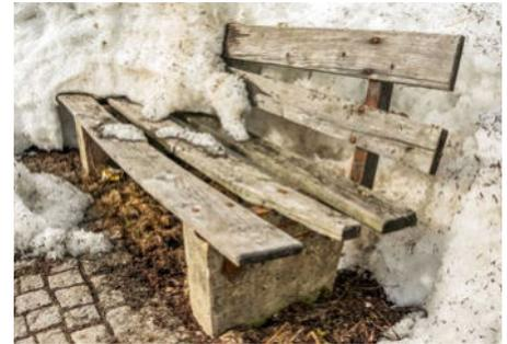
Diese Bank hat astiges und leicht rissiges Nadelholz mit unruhiger Maserung. Regenwasser kann gut ablaufen, dennoch wird sie unter den extremen Bedingungen nicht so lange halten.
