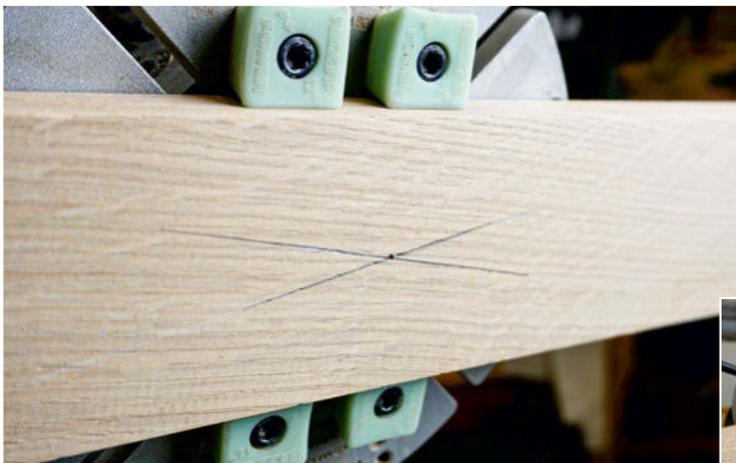
Auch beim Dreheln gilt: Je besser die Vorbereitung, desto besser das Ergebnis. Das abgerichtete Werkstück wird mittels der Diagonalen mittig eingespannt. Das Spannfutter hat austauschbare Backen, um möglichst viele Geometrien aufnehmen zu können.
