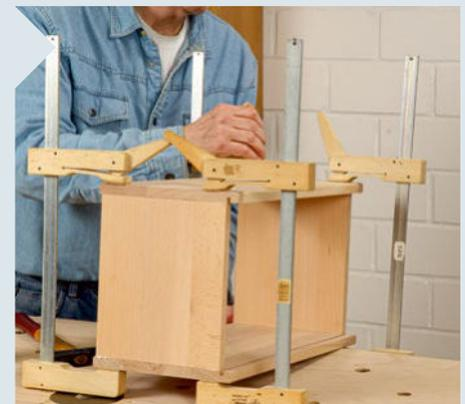
**10** Fasen Sie die oberen Längskanten leicht und verleimen Sie die Schubkästen. Vor der Boden- und der Beschlagmontage werden alle Schubkästen sowie der gesamte Korpus mit einem zweimaligen Anstrich behandelt.
