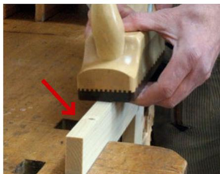
Wenn Sie ganz leicht schräg hobeln und von der hinteren Kante etwas mehr Material abnehmen (Pfeil), lässt sich trotz außenliegendem Drehpunkt sogar eine Fuge mit Null Luft realisieren.
