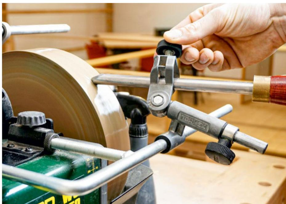
Vor allem die Schneidengeometrie der Röhren erfordert für Einsteiger eine Schleifführung. So lässt sich innerhalb weniger Sekunden wiederholgenau eine scharfe Schneide herstellen. Ein Nass-Schleifer sorgt dabei für einen geringen Abtrag gegenüber dem Trockenschleifer. So haben Sie länger etwas von Ihren Eisen.
