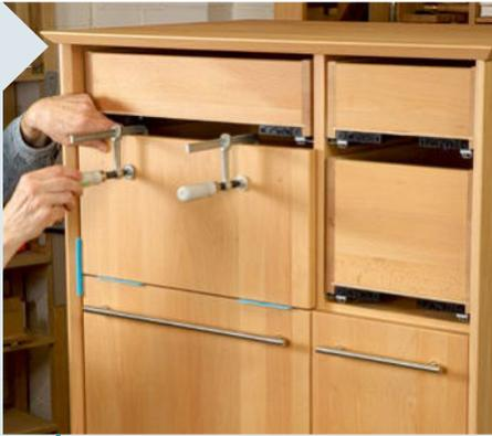
**23** Bei Blenden aus Massivholz sollten Sie mindestens 2,5 - 3 mm Luft ringsum einplanen. Dazu können Sie Verglasungsklötz (hellblau) als Distanzstücke einsetzen und die mittlere Blende zum Verschrauben mit kleinen Zwingen fixieren.
