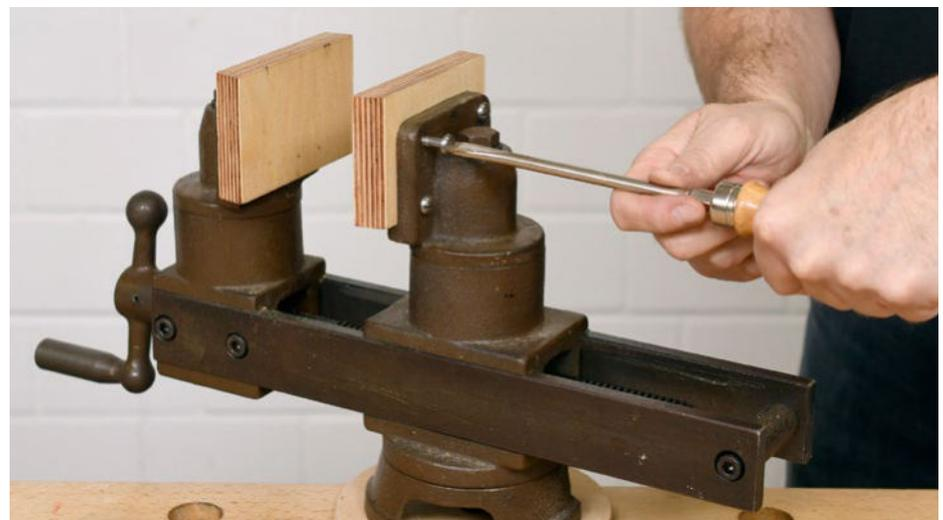
Wir verpassen dem Spannstock noch ein Upgrade: Dazu werden beide Holzbacken entfernt und an ihrer Stelle zwei Haltebretter aus Multiplex angeschraubt. Sie sind an den aufrechten Kanten um 12° schräg gesägt.
