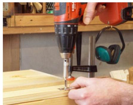
Sie sollten selbstzentrierende Scharnierbohrer einsetzen, um genau in der Mitte der Schraubenlöcher der Lappen im Holz vorzubohren. Es gibt sie mit Bohrern verschiedener Durchmesser. Ungenaueres Vorbohren bewirkt ein Verschieben des Beschlags.
