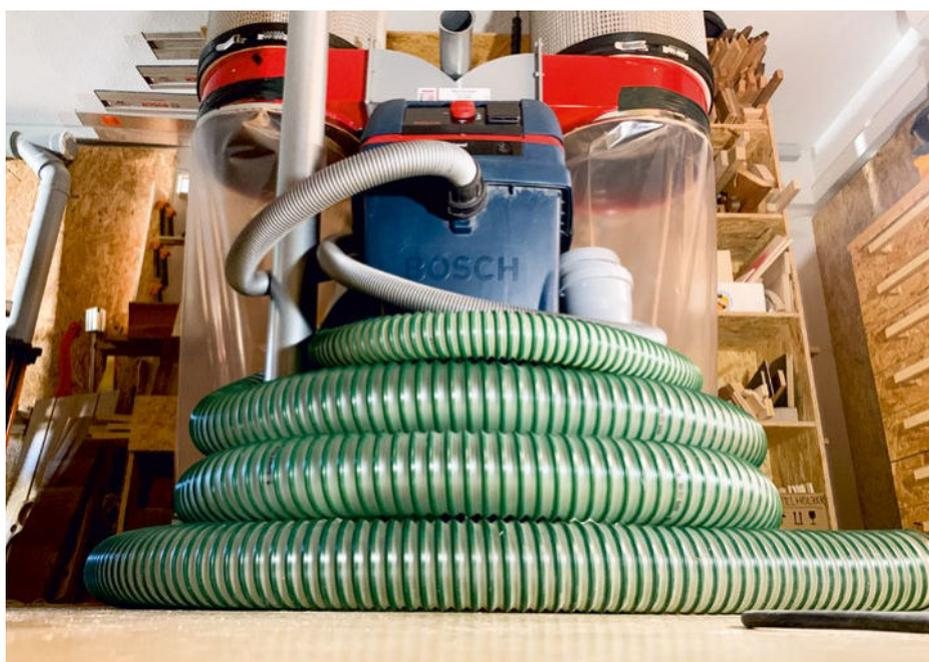
Effiziente Absaugung in der Holzwerkstatt: Eine durchdachte Kombination aus flexiblen Schläuchen, Rohren und Absauganlagen minimiert Staub und sorgt für saubere Luft.
