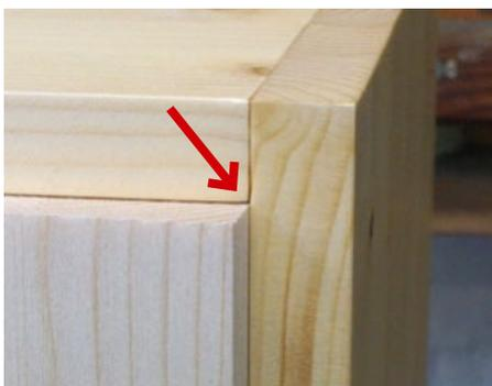
Die einschlagende Tür stößt beim Schließen aufgrund des vor der Fläche liegenden Drehpunktes mit der hinteren Kante an die Korpusseite (Pfeil). Mit dem Putzhobel können Sie das aufrechte Rahmenholz anpassen, damit es sauber in den Korpus einschlägt.
