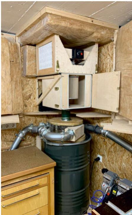
Eigenkonstruktion einer LVHP-Absaugung als Ersatz für den Werkstattsauger: Dreistufige Filterung mit HEPA-Filtern; zwei Turbinen mit je 1.400 Watt.
