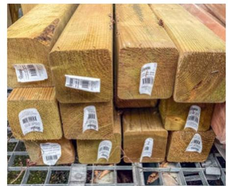
Die Balken aus Nadelholz sind Kesseldruck-imprägniert und müssen entsprechend gekennzeichnet sein.
