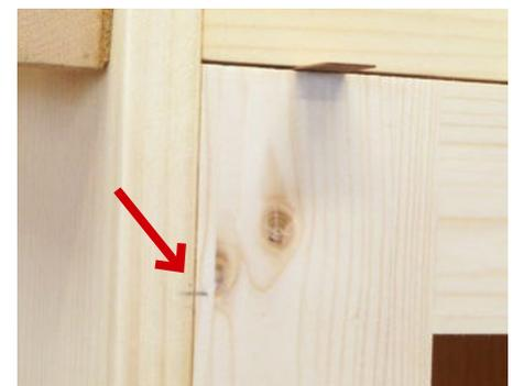
An der Anschlagseite wird die Position der Bänder durch einen waagerechten Strich (Pfeil) auf Seite und Tür festgelegt. Er markiert die Stelle, an der die beiden Rollen des Bandes aufeinandertreffen, und hilft beim Anzeichnen der Lappenformen auf den Flächen.
