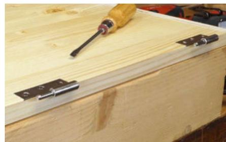
Bei exakt platzierten Lippenbändern liegen die Längskanten beider Beschläge auf einer Linie – somit auch die beiden Zapfen. Die Vorderkanten sind bündig mit der Plattenkante und die Flächen auf einer Ebene mit der Holzoberfläche.
