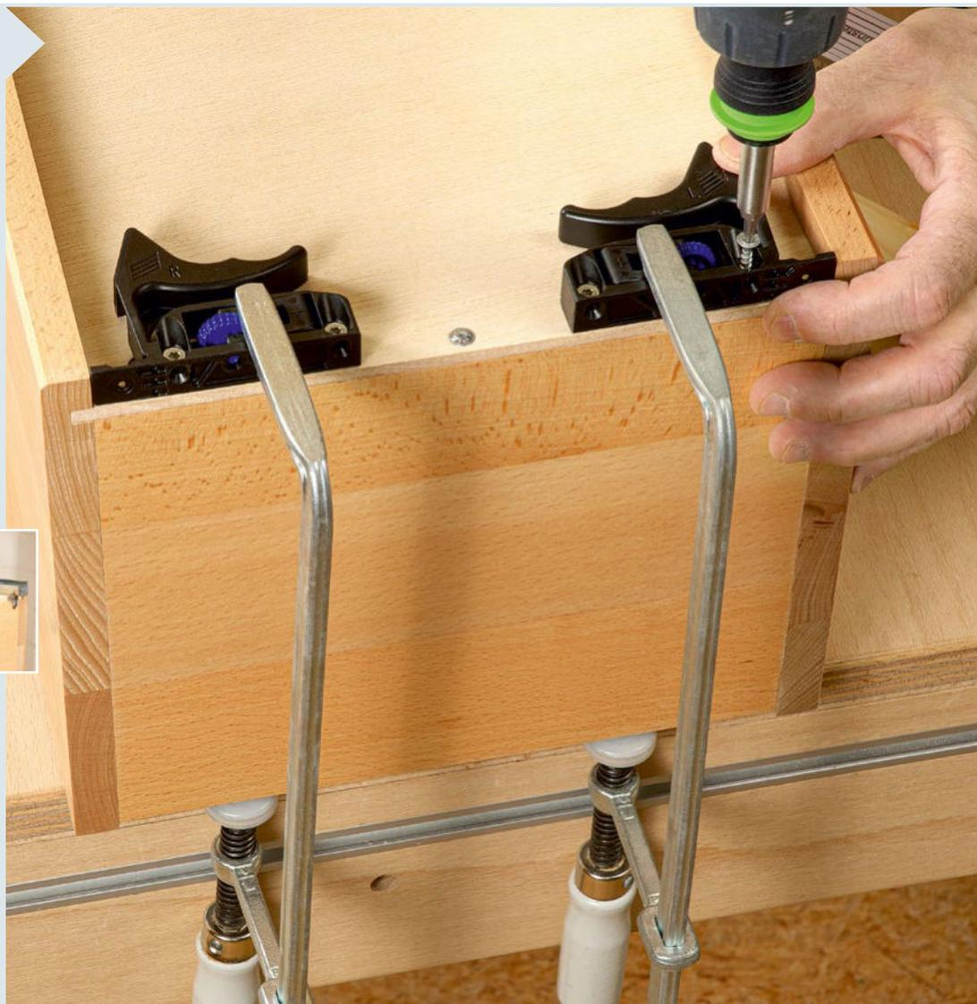
**13** | Danach schrauben Sie am Vorderstück links und rechts je ein Kupplungsstück fest. Dazu die Kupplungen bündig zum Vorderstück und dicht an den Seiten anlegen und fixieren.
