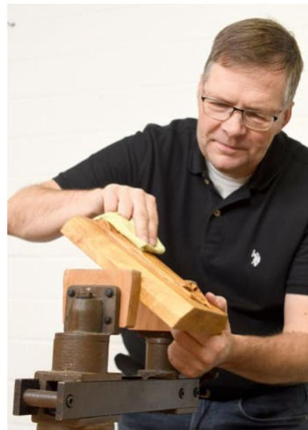
Schon die Augen und den Rücken: Ist der Schraubstock einmal auf der Hobelbank montiert, hebt er das Werkstück um etwa 25 Zentimeter an.
