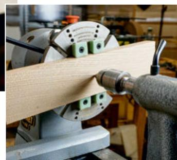
Mit Hilfe der kugelgelagerten Mitläuferspitze kann das Werkstück nun mittig positioniert werden. Je exakter beim Einspannen vorgegangen wird, desto geringer ist die Unwucht und somit auch die Bearbeitung.
