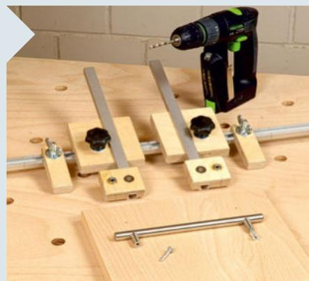
**16** | Alle Blendenkanten brechen Sie nun mit einer 2-mm-Fase. Danach bohren Sie 50 mm von der Oberkante entfernt die beiden Grifflöcher. Das geht besonders einfach mit der Griffbohrlehre aus **HolzWerken 104**.
