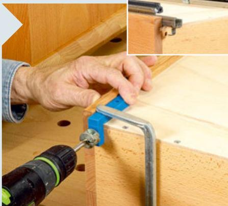
**12** | Im Rückstück bohren Sie als nächstes links und rechts außen je ein 6 mm großes Sackloch für den Aufsteckhaken (kleines Bild). Zu sehen ist hier die Bohrlehre „BlueJig Quadro Start“ (Hettich).
