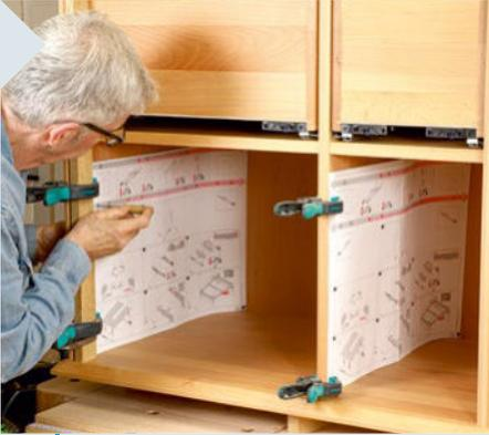
**17** Nun zur Innenausstattung: Im Set des Mülltrennsystems befindet sich eine große Kartonschablone, mit der Sie die Schraubpositionen der Auszugschienen und später die Blendenwinkel sehr genau ankönnen können.
