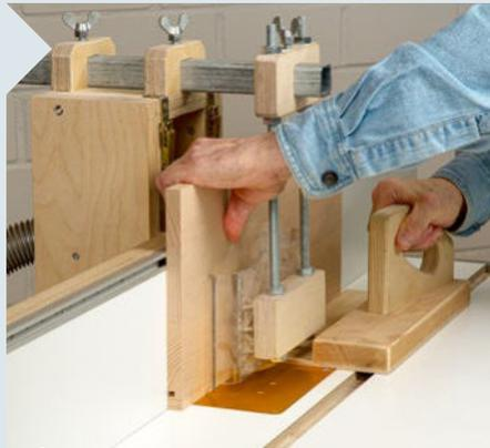
**8** Wenden Sie sich nun den Schubkästen zu. Sind die Teile zugeschnitten, fräsen Sie in alle Seitenteile mit einem Scheibennutfräser eine 7 mm tiefe Nut für den 5 mm-Sperrholzboden. Die Unterkante des Fräsers muss 12 bis 13 mm hoch eingestellt werden. Der Boden des Schubkastens darf nicht zu stramm in der Nut sitzen, weil er geölt wird.
