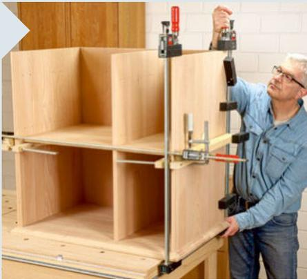
**7** Kontrollieren Sie beim Verleimen immer wieder den rechten Winkel. Nach einer weiteren zweistündigen Trocknungszeit geht es weiter mit dem schmalen, rechten Zwischenboden und der rechten Seitenwand. Im letzten Schritt verleimen Sie den Deckel (Pos. 2).
