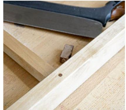
Ein kleiner Dübel sorgt für die Verdrehsicherung. Wer mag, sorgt mit dunklem Holz für etwas Kontrast.
