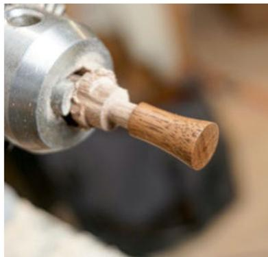
Der gedrechselte Griff aus Nussbaum wird an der Drechselbank geschliffen und geölt. Der Zapfen bekommt dabei selbstverständlich kein Öl, um hinterher noch Leim aufnehmen zu können.
