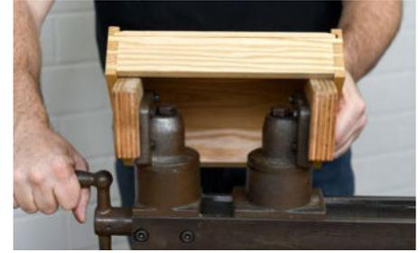
Sind beide Backen um 180° gedreht, verrichten sie beim Drehen der Kurbel Spreizarbeit; zum Beispiel, um einen Schubkasten schonend auseinanderzudrücken.
