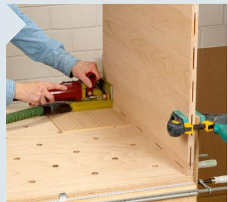
**3** Um die Schlitz für die Rückwand zu fräsen, fixieren Sie die Seitenwand hochkant auf der Werkbank. Damit die Rückwand exakt 5 mm zurückspringt, legen Sie einfach ein 5 mm dickes Stück Sperrholz unter die Flachdübelfräse.
