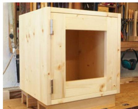
Das Ergebnis ist eine einschlagende Tür, deren Vorderseite mit den Korpuskanten bündig abschließt. Die Lippenbänder prägen durch Material und Form das Erscheinungsbild des Möbels. Andere Bandformen ermöglichen weitere Anschlagsituationen.
