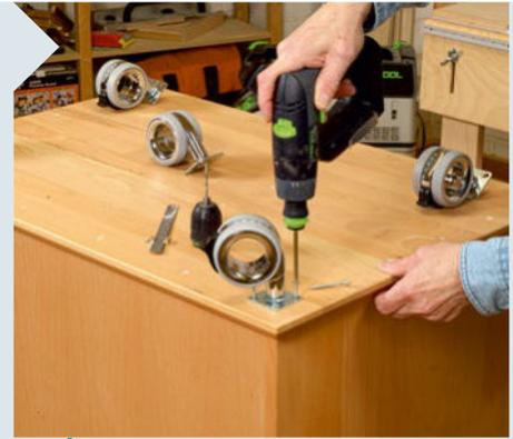
**25** Befestigen Sie die vier äußeren Rollen so, dass sich mindestens zwei lange Schrauben im Bereich der Seitenwände befinden. Aufgrund des hohen Gewichts sollten Sie auch in der Mitte des Bodens noch eine Rolle montieren, sonst hängt der Boden durch.
