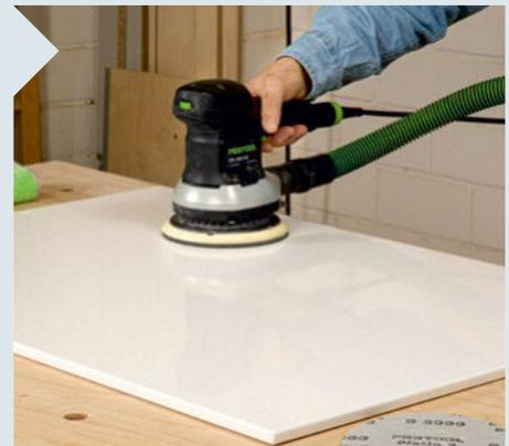
**28** Die Außenfläche und die Kanten schleifen Sie mit dem Exzentrerschleifer im Kreuzgang schrittweise mit den Körnungen P 180, P 280, P 500, P 1.000, Schleifpad S 2.000 und S 4.000. Das ergibt einen seidenmatten Glanz, der optimal für beanspruchte Flächen ist.
