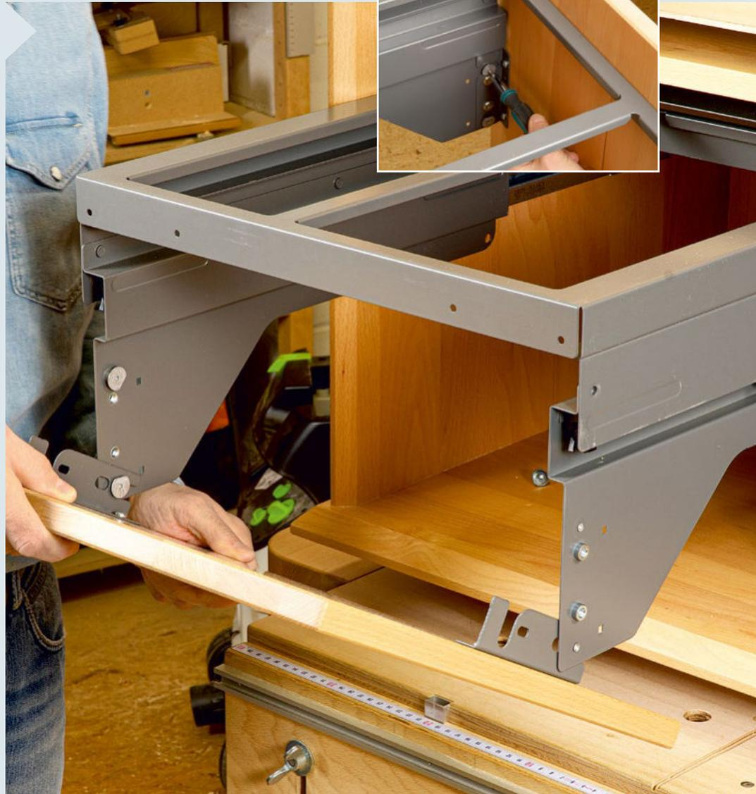
**22** Hängen Sie die Blende ein. Sichern Sie sie mit den M6-Schrauben. Über die obere Exzentrerschraube (kleines Bild) justieren Sie die Blendenhöhe, mit der unteren die Neigung. Die seitliche Position korrigieren Sie über die Langlöcher im Blendenwinkel.
