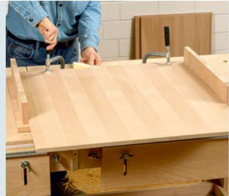
**1** Beginnen Sie mit dem Korpus. Sind alle Korpusteile exakt auf Maß zugeschnitten, legen Sie die Rückwand auf die Deckelplatte, richten Sie die Rückkanten bündig zueinander aus und sorgen mit Restabschnitten links und rechts für einen gleichmäßigen Abstand.
