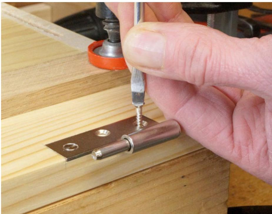
Vorbohren erleichtert das Eindrehen der Schrauben ins Holz. Bei harten Hölzern hilft etwas Fett an der Schraube zum leichten und senkrechten Eindrehen. Arbeiten Sie vorsichtig: Ein Abrutschen mit dem Schraubendreher hinterlässt Kratzer auf dem Beschlag.
