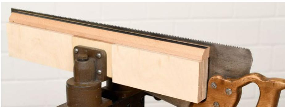
Und mit besonders langen Aufsteck-Backen spannen Sie filigrane Hobelarbeiten auf Länge ein. Oder Sie verwandeln den Spannstock wie hier in eine Kluppe zum Schärfen von Handsägen.
