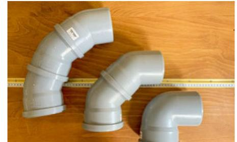
HT-Rohre im Vergleich: Drei Varianten für eine 90-Grad-Biegung in der Absaugung von Holzwerkstätten. Je größer der Radius, desto ungehinderter strömt die Luft und der Strömungswiderstand wird reduziert.
