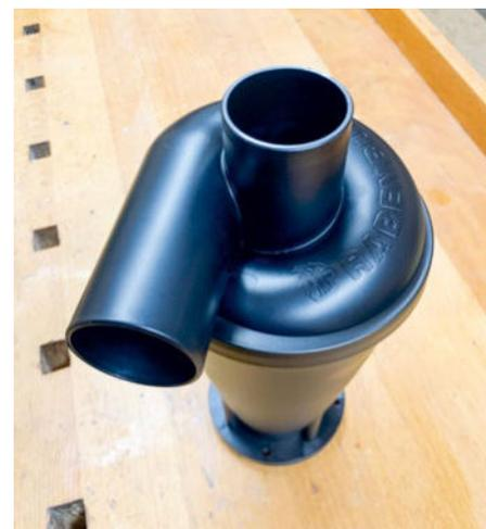
Ein Zyklonabscheider trennt Späne und Luft. Er benötigt eine Bauhöhe von 30 bis 40 cm.
