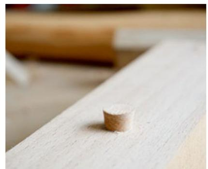
Eine weitere Besonderheit: Der Propfen ist aus Querholz gedrechselt; die Faserrichtung des Holzes liegt also quer zur Drehachse. Der Stopfen passt daher sowohl optisch als auch von den Quellmaßen hervorragend in die Fehlstelle.
