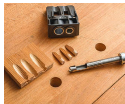
Die Holzdübel zum Verschluss der Löcher sind in Sekundenschnelle aus Restholz hergestellt. Ihre Güte ist allerdings unterschiedlich.
