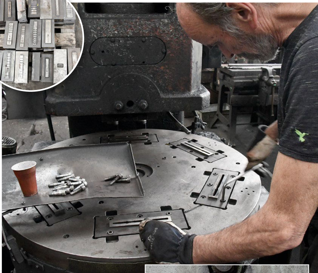
In die Presse für die weitere Formgebung werden verschiedene Pressformen eingelegt. Das passiert noch händisch.
