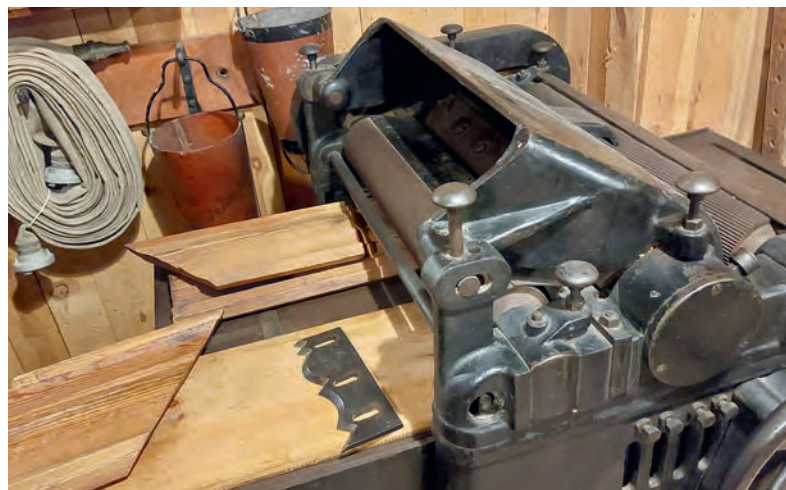
Heute kaum vorstellbar: Dieser alte Dickenhobel konnte nicht nur gerade, parallele Flächen herstellen. Mit dem richtigen Messer (in der Mitte liegt vorne eines) wurden Profile für Fußleisten und den Möbelbau hergestellt. Das ist heute aus gutem Grund verboten.
