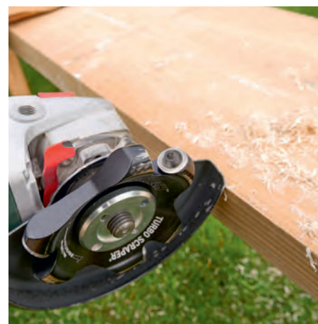
Der Aluminiumkörper trägt drei runde Wolframkarbid-Scheiben. Deren Form bedingt, dass man sie einfach „nach hinten“ drehen kann, wenn sie stumpf sind.
