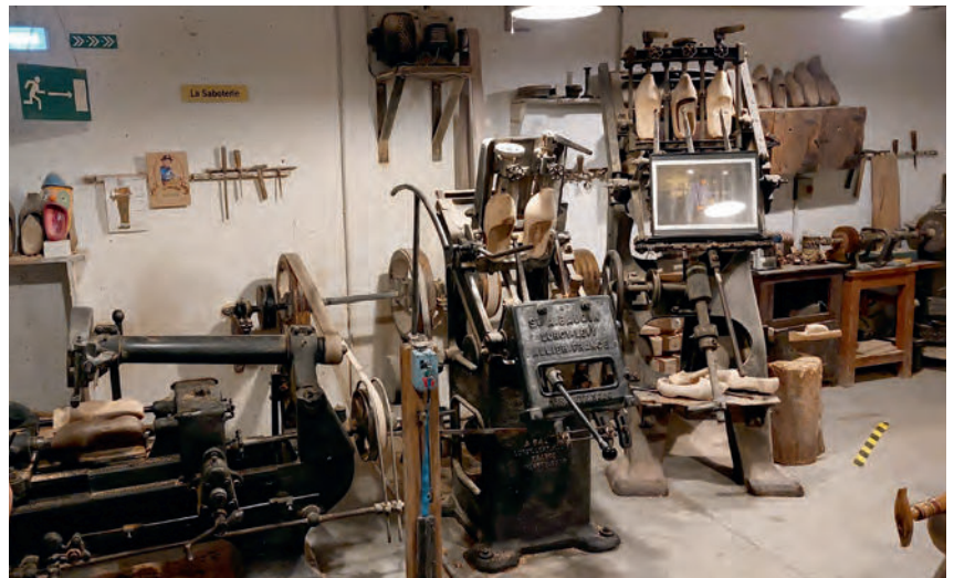
Holzschuhe werden in kleinen Manufakturen noch immer in ähnlicher Weise hergestellt. Die Kopierfräse in der Bildmitte stellt den inneren Bereich des Schuhs her, während die Schuhe ihre äußeren Konturen auf einer Drechselbank mit Kopierfunktion erhalten (links im Bild).
