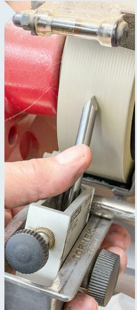
**8** | Ohne umzuspannen wird nun die Kopffläche auf 30° angeschliffen. Das ist auch die Fläche, auf der das Werkzeug nachgeschärft wird. Nach dem Verfeinern aller drei Flächen auf dem Nassschleifer ist das asymmetrische Point-Tool fertig.
