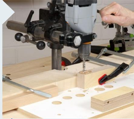
**2** Auf dem Bohrständer bohren Sie anschließend in alle Stangenadapter mit einem 8,5-mm-Bohrer die beiden Löcher für die Führungsstangen. Nutzen Sie links und rechts Anschlagleisten zur ...
