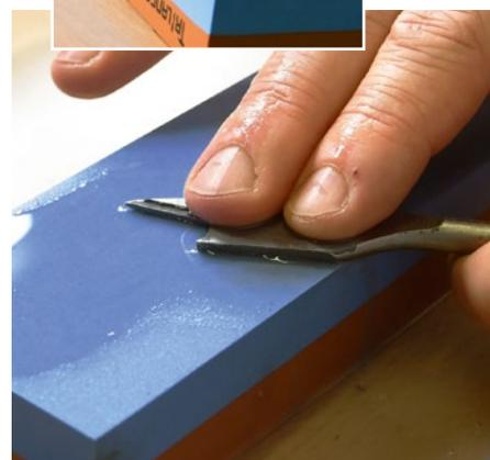
Ziehen Sie dann die flache Seite noch kurz auf einem Schärffstein ab. Auch die Schmalseiten können Sie so bearbeiten. Der geringe Materialabtrag verändert die Bohrerbreite nur minimal. Der Flachbohrer wird aber sowieso nicht für Präzisionsarbeiten eingesetzt.
