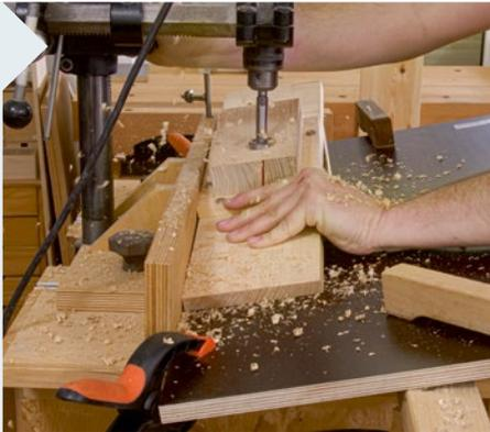
**4** | So bohren Sie von der Oberseite jeder Gratleiste einmal mit 30 mm hindurch: 40 mm vom Hirnende entfernt liegt der Bohrpunkt und in Längsrichtung 8 mm von der Mitte versetzt. Das gewährleistet, dass der Austritt der Bohrung unten mittig liegt.
