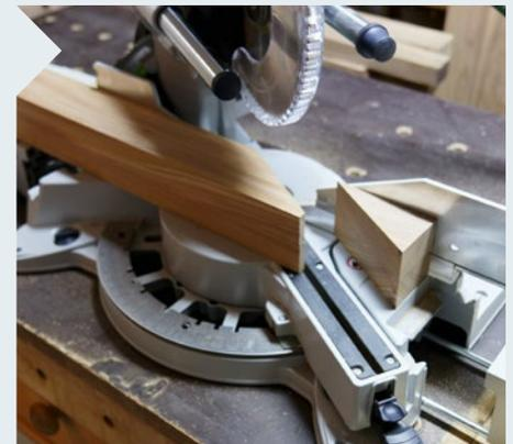
**5** Die Gratleisten bekommen ihren Grat am Frästisch mit einem 15°-Fräser. Sägen Sie anschließend beide Gratleisten zusammen; so werden sie exakt gleich lang. Vor dem Einschleiben in die Tischplatte sollten Sie die äußeren Kanten abrunden.
