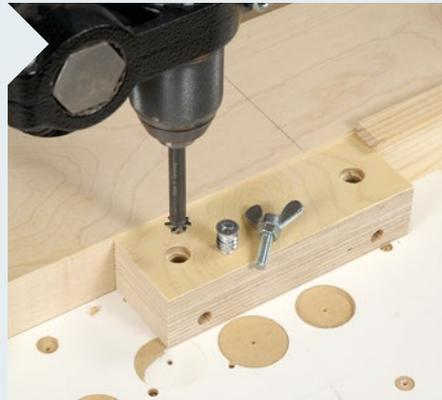
**5** Bei der „selbstgebauten“ Variante wird die Flügel- oder Sterngriffmutter mit einer M6-Mutter gekontert. Senken Sie dann die Bohrung noch etwa 6 mm tief an. Dann steht die Flügelmutter später nicht so weit aus dem Adapter heraus.
