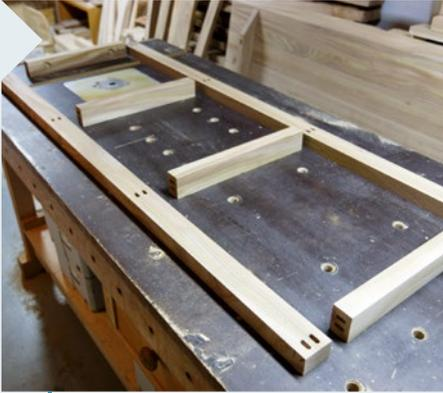
**13** Fräsen Sie bei den Dübellöchern (8 x 50 mm) für den Rahmen eine Verbindungsseite mit Spiel; das erleichtert auch hier das Ausrichten. Die Kanten der Längszargen erhalten an den Außenseiten eine Abrundung ( $r = 15$  mm).
