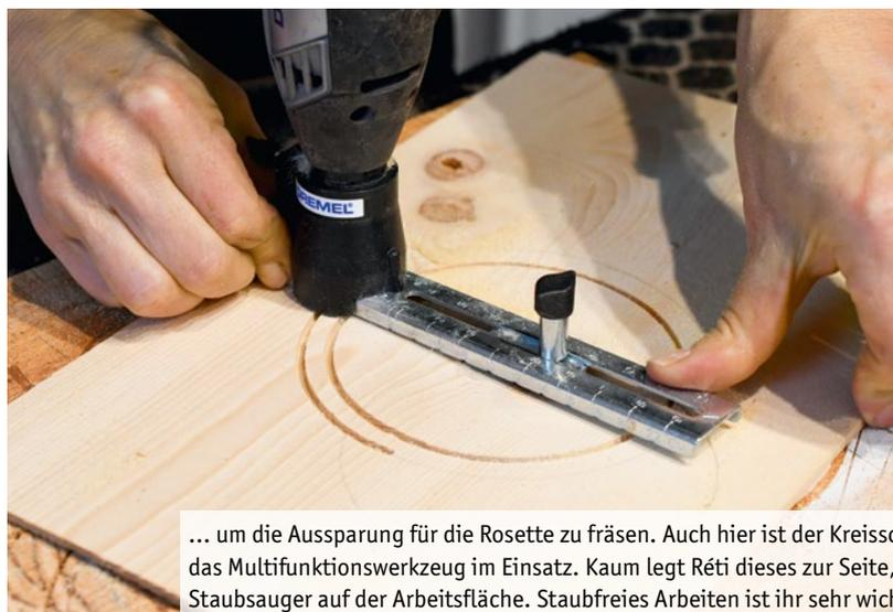
... um die Aussparung für die Rosette zu fräsen. Auch hier ist der Kreisschneider für das Multifunktionswerkzeug im Einsatz. Kaum legt Réti dieses zur Seite, erscheint der Staubsauger auf der Arbeitsfläche. Staubfreies Arbeiten ist ihr sehr wichtig.
