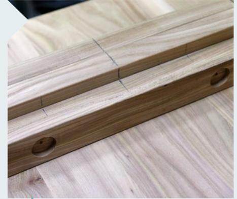
**15** Setzen Sie den Rahmen auf die auf dem Kopf liegende Tischplatte. Richten Sie ihn an den Gratleisten aus und bringen Sie Markierungen für die spätere Montage an.
