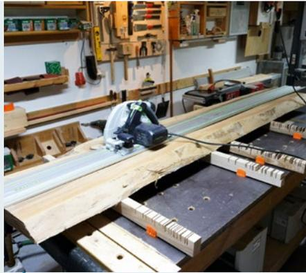
**1** Suchen Sie die besten Stücke aus den Bohlen: Stehende Jahrringe helfen, ein starkes Arbeiten zu verhindern. Wenn ein exaktes Endmaß der Platte von 30 mm gewünscht ist, addieren Sie ein bis zwei Zehntel Aufmaß, das beim späteren Schleifen egalisiert wird.
