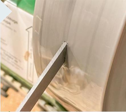
**4** | Der Abstecher aus einem flachen Rohling (2x10x100 mm) wird in der Multi-Vorrichtung (Tormek) gespannt. Die 60°-Freifläche entsteht noch auf dem Schleifbock und wird mit dem Nassschleifer verfeinert. Zuletzt wird noch die Spanfläche leicht touchiert.
