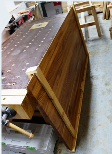
**22** | Auf geht's: Ein einfacher Rahmen aus Dachlatten schützt die Platte beim Transport. Fixieren Sie ihn unbedingt so, dass ein Verrutschen während des Transportes verhindert wird.
