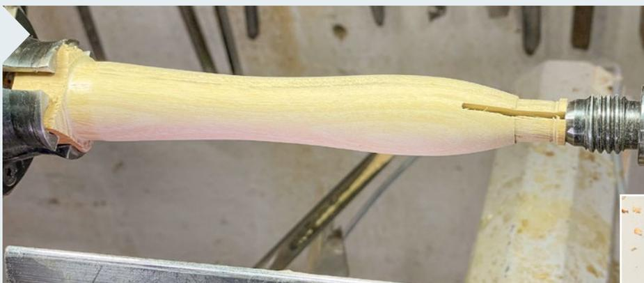
**14** | Das Heft für den Abstecher wird noch als Vierkant geschlitzt, mit der Bandsäge (oder wie hier) mit einem 2-mm-Kreissägeblatt. Am Reitstock ist dann eine Druckring-Spitze nötig, um Spaltung zu vermeiden. Das Werkzeug wird dann mit Sekundenkleber eingeklebt, und dann erst die Zwinge aufgedrückt.
