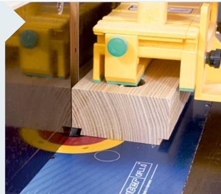
**11** | Fräsen Sie zunächst ein Teststück, um die Höhe des Grats zu kontrollieren. Tasten Sie sich danach mit immer weiter nach hinten versetztem Anschlag vor: Es werden immer beide Seiten der Gratleiste gefräst...
