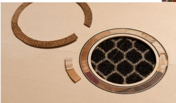
Weitere Hölzer können zu einem Farbverlauf rund um das Schalloch zu einem dekorativen Muster kombiniert werden. Dank der Vorrichtung stimmt der Anschluss zwischen den Kreissegmenten immer. Adern rings um den Ring runden die Rosette ab.
