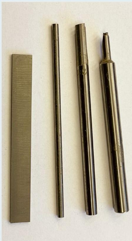
**1** Für unsere Drechselwerkzeuge können wir Rohlinge, bei denen es sich um HM-Bohrer, HM-Reibahlen oder -Fräuserschäfte handeln kann, bei einem gut sortierten Schrotthändler oder bei Hartmetallherstellern und -händlern beziehen.
