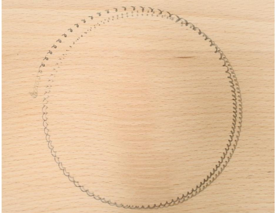
Der Schwingkreis gibt an, wie groß die Bewegung jedes einzelnen Schleifkorns auf seiner Spur ist. Eine auf dem Teller befestigte Bleistiftmine hat hier den Weg gut nachvollziehbar aufs Holz gebracht.
