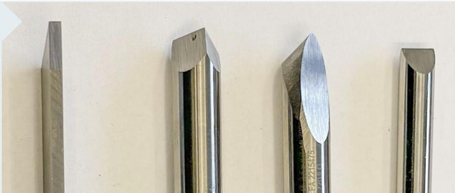
**9** | Diese vier Stähle genügen für die schabende Bearbeitung von Steinen. Von rechts: der Meißel zur groben Formgebung, der Fingernagel-Schaber für Innenrundungen, das Point-Tool für spitze Ein- und Außenrundungen und der Abstecher zum Andrehen von Absätzen.
