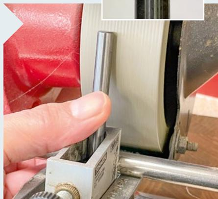
**2** Der Fingernagelschaber nutzt einen 8-mm-Rohling. Die grobe (80er) Diamantscheibe auf dem Trockenschleifbock und die Tormek-Multi-Vorrichtung (SVS-50) legen eine leicht konkave Fläche an, etwas mehr als ein Drittel des Durchmessers tief.
