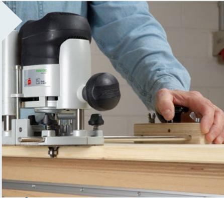
**10** | Mit den beiden Führungsstangen und einem Adapter haben Sie jetzt schon mal ein praktisches Zubehör, das das Abkippen der Oberfräse beim Einsatz eines Abrundfräsers verhindert.
