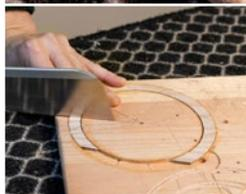
Damit die Rosetten zum echten Zierelement werden, kombiniert sie Ringe aus verschiedenen Hölzern zu Mustern. In dieser selbstgebauten Vorrichtung zerteilt sie den Nussbaumring und dann (hier zu sehen) einen aus Eschenholz mit der Japansäge.
