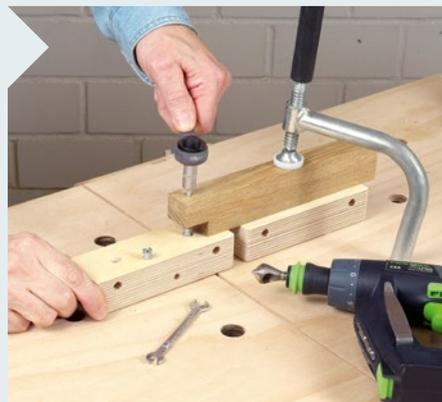
**8** Zum schnellen Ankoppeln und Anschrauben von weiterem Zubehör werden alle Adapter auf der Unterseite noch mit zwei weiteren M4-Gewindemuffen versehen.
