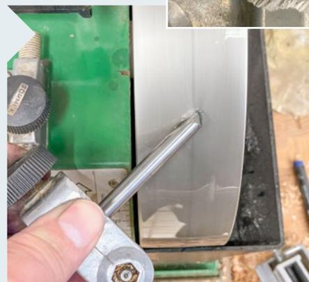
**3** Verfeinern Sie den Schliff, weiterhin in dieser Führung, auf der Tormek-Diamantscheibe (Korn 600) und wechseln Sie dann auf die Vorrichtung für Röhren. Mit dem 60°-Schneidenwinkel und „Kopfeinstellung 5“ schleifen Sie die Fingernagelform an.
