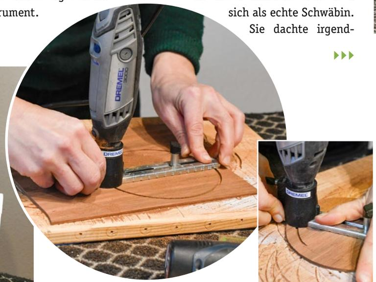
Mit dem Multifunktionswerkzeug und dem Kreisschneider fräst Gabriele Réti die dekorativen Schalloch-Rosetten aus. Im ersten Schritt entsteht ein Ring aus Nussbaum ...
