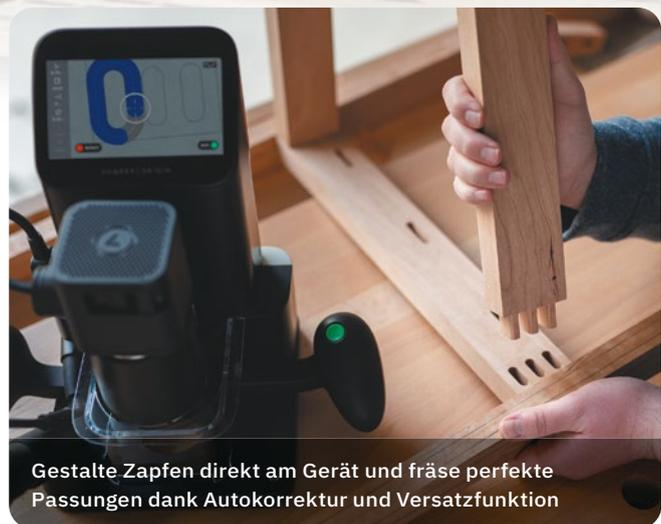
Gestalte Zapfen direkt am Gerät und fräse perfekte Passungen dank Autokorrektur und Versatzfunktion
