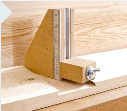
**10** | Eine Tiefenlehre (oder ein Mess-Schieber) nimmt die Nuttiefe ab und wird dann auf den im Frästisch eingespannten Gratfräser gestellt. So lässt sich die Fräshöhe sehr genau justieren. Der Fräser steht schließlich den berühmten „Hauch“ tiefer, damit die Gratfedern nicht zu hoch werden.
