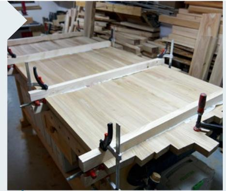
**2** Flachdübel reduzieren beim Verleimen den Versatz. Nach dem Trocknen können Sie die Platten mit einem Bandschleifer mit Aufsatzrahmen planen oder hobeln. Anschließend bringen Sie sie mit einer Handkreissäge aufs Endmaß.
