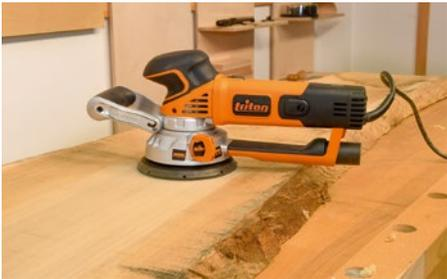
Es gibt Maschinen mit zuschaltbarer Zwangsrotation für erhöhten Abtrag. Diese Schleifer sind allerdings bauartbedingt wesentlich größer.
