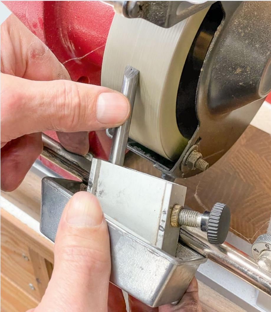
**7** | Es ergibt sich ein schräger Rundmeißel, dessen lange Spitze nicht ganz ausgeschliffen werden muss. In manchen Rohlingen vom Gebrauchtmart sind wie hier Kühlwasserbohrungen vorhanden, so dass man ihn so drehen muss, dass diese nicht stören.
