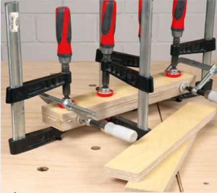
**1** Leimen Sie für die Grundkörper der Adapter zunächst je zwei 18 mm dicke Multiplexstreifen (320 x 60 mm) zusammen. Nach dem Trocknen können Sie daraus immer je zwei Stangenadapter (150 x 50 mm) zuschneiden.
