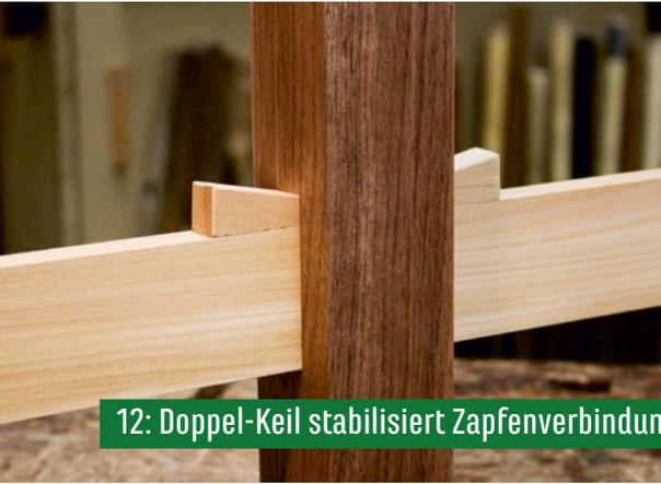
12: Doppel-Keil stabilisiert Zapfenverbindung
