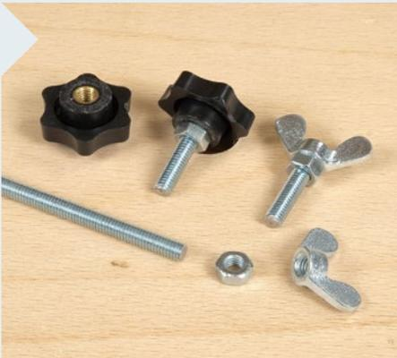
**4** Die Feststellschrauben für die Stangen können Sie fertig kaufen oder aus einer Flügelmutter, einer Sechskantmutter und einem Stück Gewinde (alles M6) selbst herstellen.
