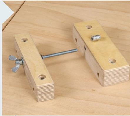
**11** | Fertigen Sie noch einen 30 mm schmalen Adapter. Drehen Sie in einen (!) der breiten Adapter eine M6-Gewindemuffe ein. Eine Gewindestange verbindet so beide Adapter. So können Sie das System auf Führungsschienen oder als Parallelanschlag mit Feineinstellung einsetzen (mehr dazu in der nächsten Ausgabe).
