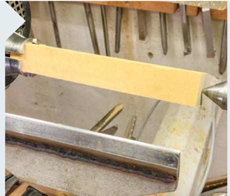
**10** | Die 30x30-Rohlinge für die Griffe längen Sie nach Wunsch auf 180 bis 200 mm ab, und nehmen sie im Zangenfutter mit Reitstockunterstützung auf. Hier verwende ich Robinie, es sind aber im Grunde alle Harthölzer denkbar.
