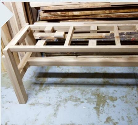
**21** | Der Rahmen wird für den Transport vorläufig mit je zwei Schrauben durch die Vertiefungen an den äußeren Querzargen mit der oberen Querzarge der Seitenteile verbunden. Die Befestigungsklötze werden nur locker eingesteckt.
