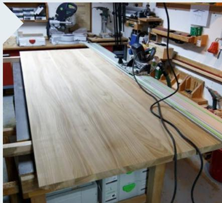
**4** Die Handkreissäge zur Herstellung der Abplattung (30°) an den Längsseiten der Tischplatte muss eine Schnitttiefe von mindestens 75 mm haben.
