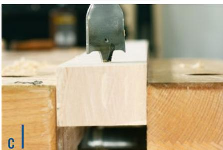
Die lang zulaufende Spitze ist ideal, um Holz von beiden Seiten zu durchbohren und so Ausrisse zu verhindern. Die Form der Spitze zeigt früh, wo der Bohrer austreten wird – so kann exakt von der anderen Seite gebohrt werden.
