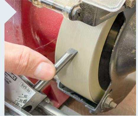
**6** | Das Point-Tool ist etwas aus der Mode gekommen. Es ist eine Kreuzung aus Schaber und Meißel, und ermöglicht Schaben mit angelegter Fase. Mit der auf 20° gestellten Multi-Vorrichtung werden zuerst die Seiten des 8-mm-Rohlings unter circa 60° geschliffen.
