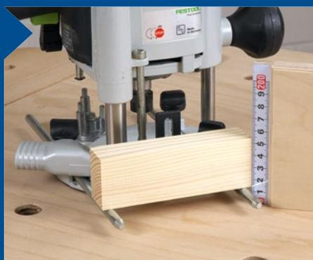
**2** Um die Höhe der Stangenmitten zur Grundplatte auszumessen, legen Sie eine Leiste über die Stangen, messen den Abstand zur Tischfläche aus und ziehen von diesem Wert eine halbe Stangendicke (hier: 4 mm) ab.
