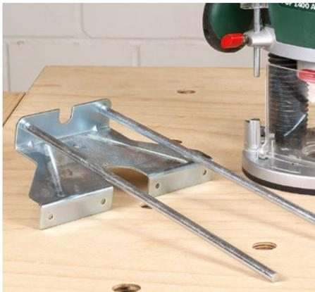
Günstigen Einsteiger-Oberfräsen liegen oft minderwertige Parallelanschlüge aus gekantetem Blech bei. Und sinnvolles Zubehör wie Feineinstellung oder Kippschutz wird gar nicht angeboten.
