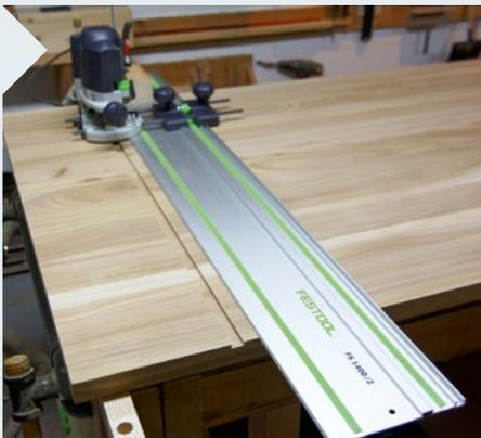
**3** Fräsen Sie die 15°-Gratnuten rechtwinklig zur Plattenkante. Um den Gratfräser zu schonen, können die Nuten zunächst mit einem Spiralnutfräser oder einer Tauchsäge geräumt werden. Beide Nuten werden nur an einer Längsseite der Tischplatte durchgefräst.
