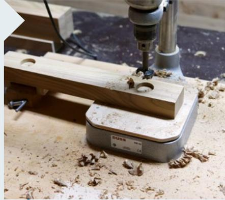
**14** Die Quersargen erhalten eine Vertiefung (10 mm tief), für die Aufnahme der Schraubenköpfe.
