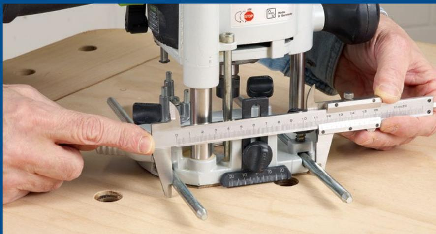
**1** Den Abstand zwischen den Stangen messen Sie mit einem Mess-Schieber aus und ziehen von diesem Wert eine Stangendicke (hier: 8 mm) ab. Das ergibt dann den Abstand der beiden Bohrmittelpunkte.
