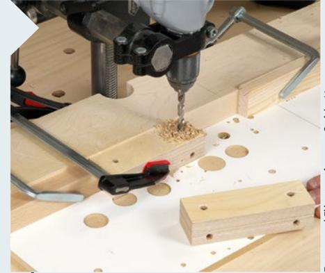
**3** ... Positionierung der Adapter. Lassen Sie die Anschläge in Position und spannen Sie einen 10,5-mm-Bohrer ein, um die nötige Kernbohrung für M6-Gewindemuffen in die flache Seite der Adapter einzubringen. So treffen die Feststellschrauben später exakt die Stangen.
