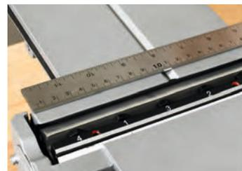
Satte 180 mm reine Hobelweite sind möglich. Diese Breite erklärt auch die ausladenden Dimensionen des Hobels: Die Maschine braucht eine große Führungsfläche.
