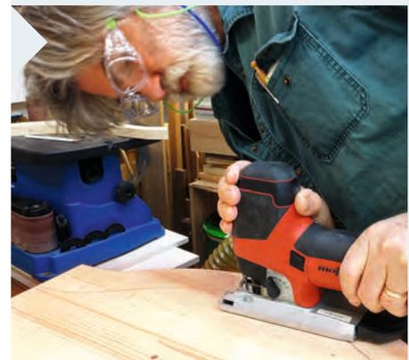
3 Ein Kurvenlinal ist ideal zum Anzeichnen der gebogenen Form der Tischbeine. Nutzen Sie zum Sägen ein feinzahniges Sägeblatt. Führen Sie die Maschine mit langsamem Vorschub. Kurz vor Schnittende halten Sie das Werkstück mit einer Hand hinter der Maschine fest.
