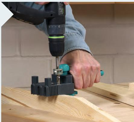
8 Setzen Sie diesmal einen Holzbohrer mit Zentrierspitze ein und stecken Sie diese Spitze in die Ankönpunkte. Mit der Dübelhilfe können Sie nun auch die Gegenlöcher senkrecht einbohren.
