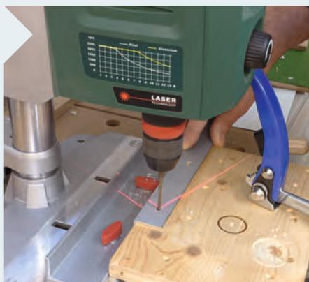
**11** Ebenfalls an der Ständerbohrmaschine werden Löcher in die Winkelschienen gebohrt. Das mittlere Loch ist normal rund. Die daneben liegenden Löcher sollten Langlöcher sein. Damit wird das Schwinden und Quellen der Tischplatte nicht behindert.
