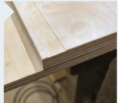
**6** Auch die einen Millimeter tiefe Nut für das Maßband muss nun gefräst werden. Schieben Sie die Lade dann mit den Streifen in den Nuten so auf die laufende Kreissäge, dass sie schon weit eingeschnitten wird.
