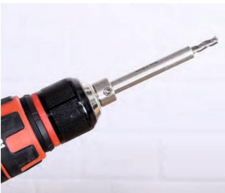
Die Fräsbohrer passen in jedes Standard-Bohrfutter.
