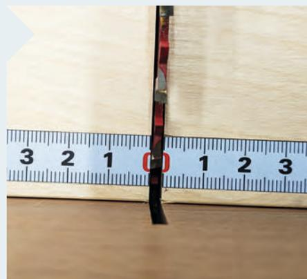
**8** Die beiden Skalen werden so eingeklebt, dass ihr Nullpunkt je genau an den Schnittkanten (links beziehungsweise rechts) liegt. Die Skalen auf der Fläche haben den Vorteil, dass sie mit jedem Anschlagreiter zu verwenden sind.
