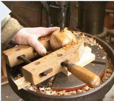
**14** | Durchbohren Sie den Apfel mittig, aber leicht schräg, was etwas dynamischer wirkt. Der Bohrerdurchmesser richtet sich nach dem Pfeilschaft, ein Millimeter mehr sollte es sein.
