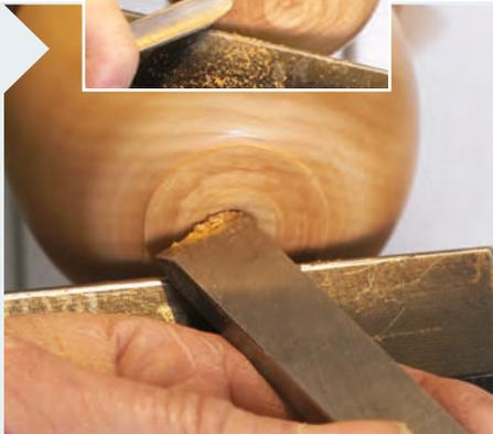
**13** | Noch einmal geht es es ins Schraubfutter (siehe Schritt 8). Die Vertiefung unten am Apfel legt der liegende Meißel an. Von außen kommt wieder die kleine Formröhre für die Feinarbeit an der Kontur, dann folgt das Schleifleinen.
