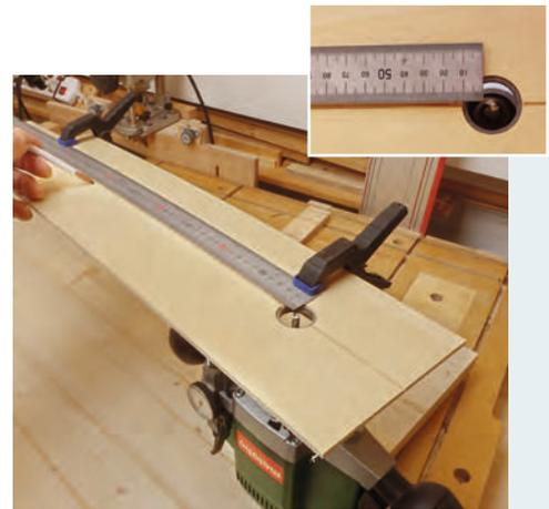
1 Die Fräse sitzt mit 30-mm Kopiererring in einem 30-mm-Loch. Von der Fräuserschneide wird der Radius von 295 mm entlang der Mittellinie gemessen. Bohren Sie hier ein 2-mm-Loch.
