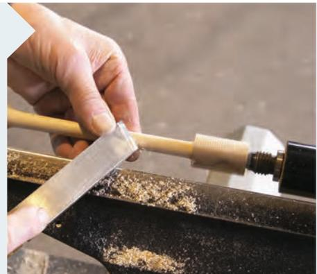
**3** Der Meißel sticht dann die Rückseite der Spitze rechtwinklig, danach schneidet er den Stiel sauber. Da das jetzt nur noch etwa 13 mm dünne Holz schnell vibriert, unterstützen Sie das Werkzeug mit der zweiten Hand.
