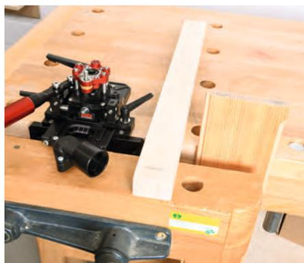
Der Nachteil: Einige Fräspositionen sind beim fixen Einbau für die Pocket Mill Pro nur schwer oder gar nicht umzusetzen.
