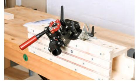
Mit der Baltic Birch Workstation erweitert man die Spannmöglichkeiten enorm. Die eingebrachten Nuten sind jedoch nur mit Zwingen von Micro-Jig kompatibel. Dafür kann die Fräsposition um bis zu 45° gekippt werden.
