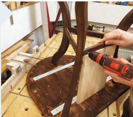
**13** | Ein Hilfsbrett (304 x 240 mm) sorgt für den gleichmäßigen Abstand der Sprossen. Sie werden mit klassischen Linsenkopfschrauben aus Messing angeschraubt und bringen zusätzliche Stabilität. Bohren Sie die Löcher unbedingt vor!
