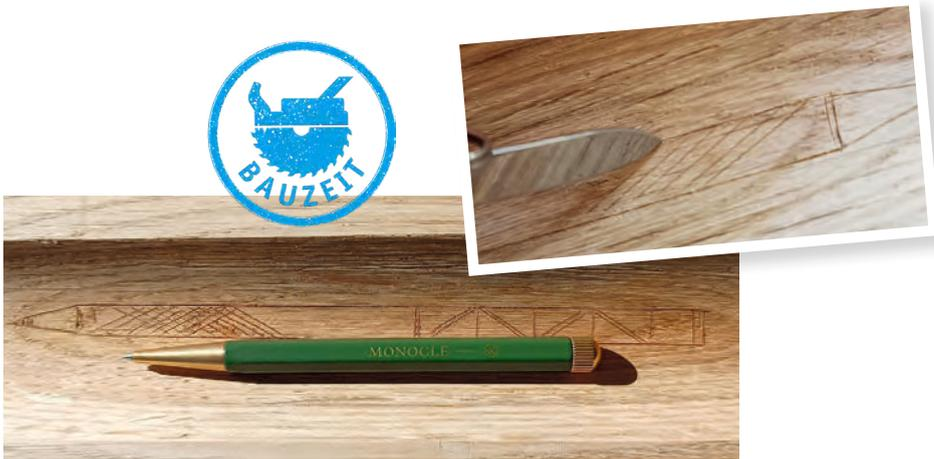
**HolzWerken-User ObelixDubois** hat mit einer Stiftablage an der ersten **HolzWerken-**Bauzeit teilgenommen. Ein Stück Brennholz diente ihm als Material, das er zunächst mit dem Schweifhobel vorbereitete. Er baute eine Vorrichtung für seine Kreissäge, um die große Hohlkehle zu erzeugen. Um sein
