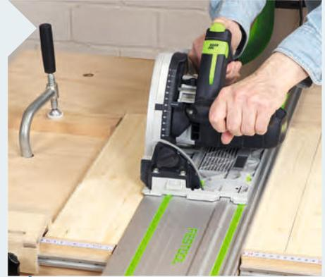
2 Mit der Tauchsäge samt Führungsschiene sägen Sie zuerst alle Rücken- und Sitzbretter exakt rechtwinklig auf 110 mm Breite und anschließend auf 470 mm Länge zu.
