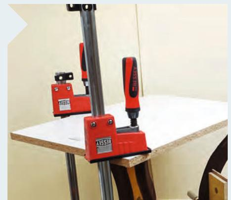
**12** Nutzen Sie beim Zusammenbau wasserfesten Leim. Eine Platte gibt gleichmäßigen Druck auf alle drei Tischbeine. Arbeiten Sie behutsam, zu hoher Druck kann zum Abscheren des Holzes führen. Gelochte Hilfsbretter helfen beim senkrechten Ausrichten der Tischbeine.
