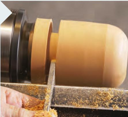
**10** | Der nächste Schritt legt die Höhe an: Hier sind es bei noch 75 mm Durchmesser etwa 85 mm. So wirkt das Stück Obst etwas schlanker und natürlicher. Der Abstecher sticht dafür etwa 20 mm ein.
