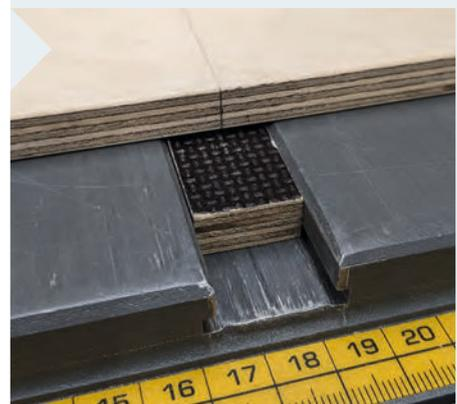
3 Richten Sie die Grundplatte mit Hilfe des Parallelanschlags über der Gleitleiste aus und befestigen Sie sie von oben mit kurzen Schrauben.
