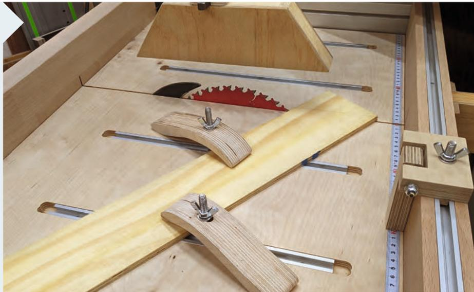
**11** | Mit Niederhaltern kann das Werkstück befestigt werden. So arbeiten Sie wirklich sicher. (Die Abdeckung ist hier für das Foto höher als normal eingestellt.)
