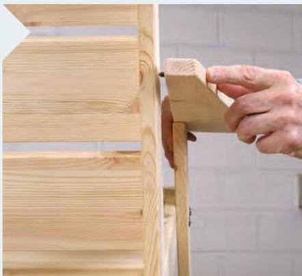
**20** | Mit einer M6-Madenschraube samt Spitze können Sie das passende Gegenloch für die Senkkopfschraube besonders einfach ankörnen. Wenn die Muffe noch nicht eingedreht wurde, können Sie zum Ankörnen auch einen 10-mm-Dübelmarkierer in der Bohrung einsetzen.
