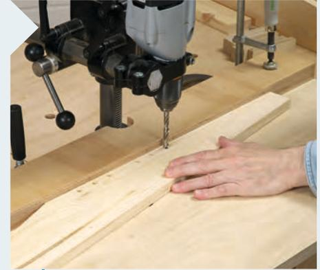
**12** Für die Gegenlöcher setzen Sie am besten einen Bohrständler ein. Die Bohrspitze stecken Sie dazu in die einzelnen Ankönnpunkte und bohren so nach und nach die 14 mm tiefen 8-mm-Dübellöcher.
