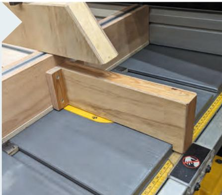
**10** | Die an die Querleiste geschraubte Einhausung des Sägeblattes verhindert, dass Kontakt zum Sägeblatt entstehen kann. Zugleich verhindert sie mit einem kleinen „Haken“, dass der Schlitten nicht zu weit geschoben wird.
