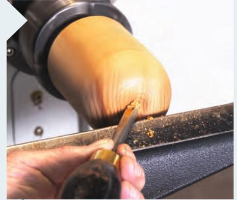
**9** | Die 10-mm-Formröhre legt jetzt die Gestalt der Oberseite an; abwechselnd vom Stielansatz nach außen und von der Außenkontur nach innen.
