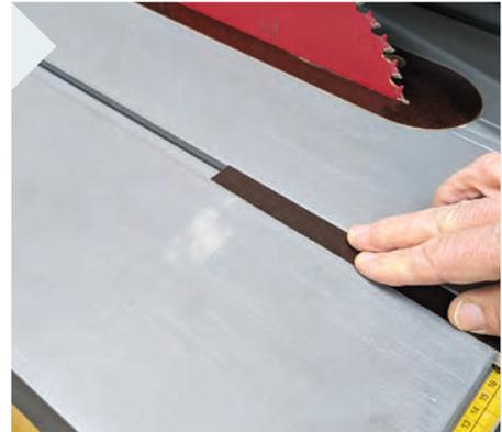
1 Die Gleitleisten aus Siebdruckplatte werden so eingepasst, dass sie sich leicht, aber spielfrei in den Nuten des Sägetisches bewegen lassen. Die letzten Feinheiten erledigt der Hobel.
