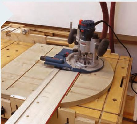
**7** Die Oberfräse ist ideal, um die Nuten für den flächenbündigen Sitz der Winkelschiene einzubringen. Die Position ist knapp neben der Position der Tischbeine, Richtung Plattenmitte. Setzen Sie eine Schiene, alternativ auch eine gerade Leiste, zur Maschinenführung ein.
