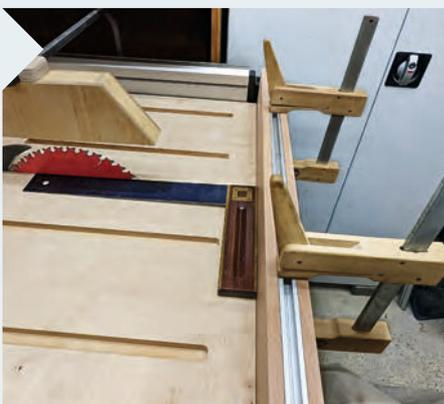
**7** Der entscheidende Schritt, der über die Genauigkeit der Querschnittlade entscheidet: Der Anschlag wird genau rechtwinklig zum Sägeblatt ausgerichtet und dann von unten mit Schrauben befestigt. Hier lohnt es sich zweimal hinzusehen.
