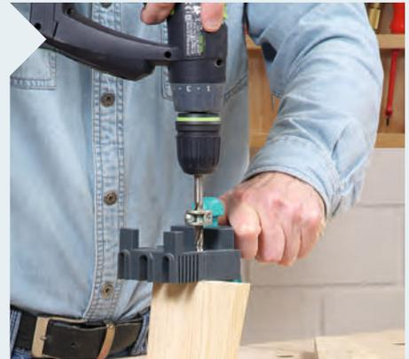
6 Die beiden Bretter für die Rückenlehne und die Sitzseite werden mit je drei Runddübeln aus Eiche verbunden. Mit einer Dübelhilfe und einem 8-mm-Metallbohrer bohren Sie zuerst die Löcher in die Stirnkanten der Rückenlehne.
