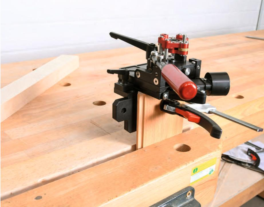
Ohne fixe Montage kann das Holz auch mit einer Zwinde unter der Pocket Mill befestigt werden. Wichtig ist allerdings, dass dann alles noch mal fixiert werden muss: Man braucht beide Hände, um die Vorrichtung zu bedienen.
