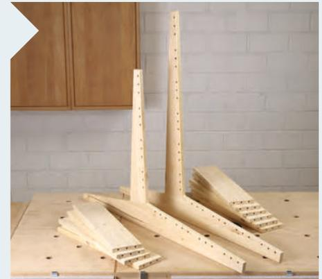
**13** Sind alle Löcher gebohrt, verleimen Sie als Nächstes die Sitzseiten mit den Rückenlehnen (je nach Modell mit hoher oder niedriger Rückenlehne). Nach dem Trocknen werden alle scharfen Brettanten ringsum noch mit einem 3-mm-Abrundfräser gerundet.
