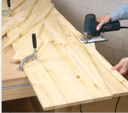
1 Zeichnen Sie alle Bauteile auf eine 18-mm-Leimholzplatte auf (250 x 60 cm). Danach sägen Sie alles grob mit etwas Übermaß mit einer Stichsäge aus.
