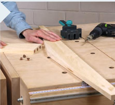
7 Stecken Sie jetzt in jedes Bohrloch eine Markierspitze (Dübelmarkierer). Auf diese Weise können Sie ganz einfach und sehr präzise die passenden Gegenlöcher in den Sitzseiten (Pos. 3) ankönnen, also einstechen.
