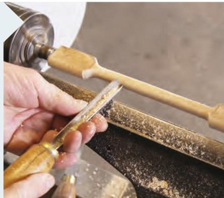
**2** Nehmen Sie mit einer schmalen Formröhre (hier: 13 mm) im Bereich des Stiels nur behutsam Späne ab. Das dünne Werkstück steht durch die Einspannung zwischen den Spitzen schließlich recht stark unter Druck.
