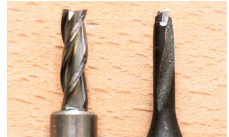
Die Schneiden des Fräsbohrers („End Mill Kit“) von Jessem (links) sind im Gegensatz zum Dominofräser von Festool komplett aus Hartmetall.
