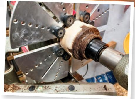
**Eine Schreibtischlampe aus Wengé und Linde** hat **HolzWerken-User** Ton Nijkamp während der ersten **HolzWerken-**Bauzeit in 16 Stunden gebaut. Die Leuchte ist einem Talon-Spannfutter für die Drechselbank nachempfunden. Den gebogenen Lampenarm hat Nijkamp entworfen, um das Kabel zu verdecken. Um die Biegung zu erreichen, hat er eine Form gebaut und einzelne Schichten aufeinandergeleimt. Im Sockel ist eine Stiftablage integriert. Die Lampe ist mit Tungöl behandelt.
