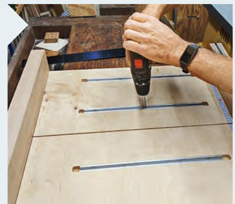
**9** Zwei T-Nut-Schienen auf jeder Seite tragen zur Sicherheit bei. Wenn das Werkstück nur an einem Punkt befestigt ist, besteht die Gefahr, dass es sich bei der Bearbeitung wegdreht.
