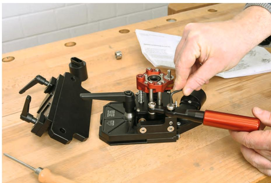
Der Zusammenbau der Pocket Mill Pro ist fummelig, ist aber eine einmalige Sache. Das System bleibt danach montiert und einsatzbereit. Praktisch: Der Hebel kann beidseitig montiert werden – das System ist also für Rechts- und Linkshänder geeignet.
