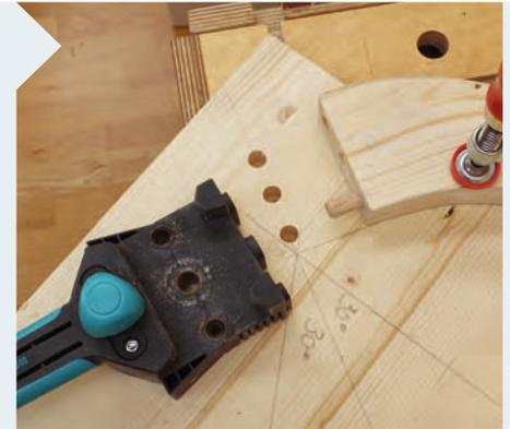
**6** Fixieren Sie das Bein mit 40 mm Abstand zur Bohrlinie auf der Tischplatte und stecken Sie einen Führungsdübel ein. Darauf platzieren Sie den 10-mm-Schlitz der Dübelhilfe und bohren 18 mm tief in die Platte. Danach den Dübel ins nächste Loch stecken, nächstes Loch bohren.
