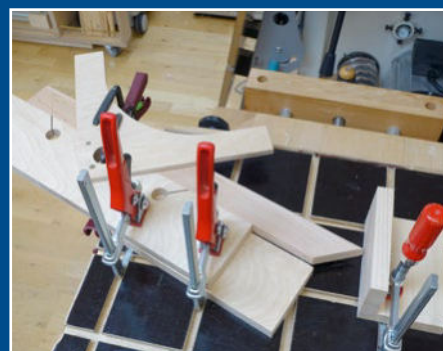
Ist die Vorrichtung fest fixiert, können Sie einen Stopfklotz (im rechten Bildteil zu sehen) positionieren. So lassen sich die Leisten beim zweiten Schnitt auf exakt gleiche Länge sägen. Sind die Leisten dicker als der Queranschlag, kann dessen Abstand zur Tischplatte durch Unterlegen eines Brettchens erhöht werden.
