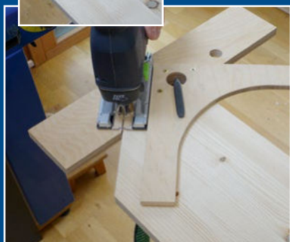
Durch die Bogenform findet eine zweite Zwinde im Bogenbereich Platz. Da die Innenkante der Leiste am Queranschlag anliegt, erfolgt der Schnitt automatisch in Faserrichtung. Das reduziert zusätzlich das Ausreißen der Schnittkanten.
