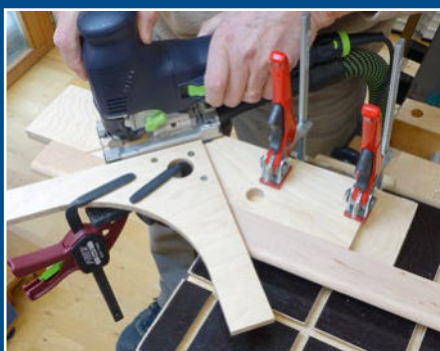
Durch die Bogenform findet eine zweite Zwinde im Bogenbereich Platz. Da die Innenkante der Leiste am Queranschlag anliegt, erfolgt der Schnitt automatisch in Faserrichtung. Das reduziert zusätzlich das Ausreißen der Schnittkanten.
