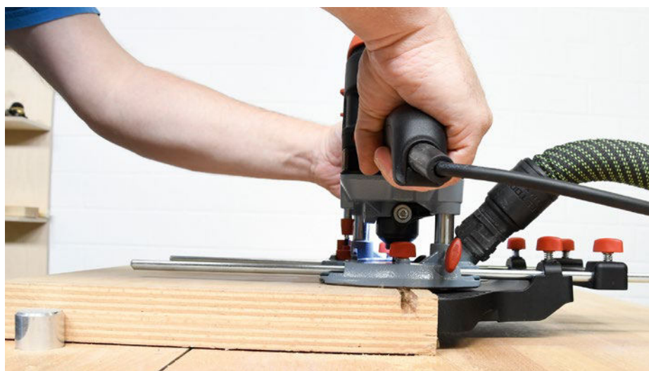
Der Absaugstutzen nimmt die meisten gängigen Staubsaugeranschlüsse auf. Die Absaugung erfolgt am Rande des Durchlasses für den Fräser in der Grundplatte. Zusammen mit dem eingesetzten Absaugadapter – der allerdings nur Platz hat, wenn kein Kopiering oder ähnliches genutzt wird – macht das die Arbeit zufriedenstellend sauber und lässt einen freien Blick auf den Fräser zu.
