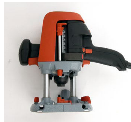
Die eigentliche Fräse ist überraschend klein und handlich – nur 3.100 Gramm bringt die L055 auf die Waage. Praktisch: Durch ihre Form kann sie beim Fräserwechsel auch auf den Kopf gestellt werden.
