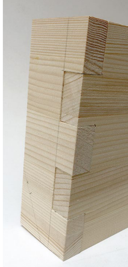
Diese Fingerzinken wurden mit der Pendelstichsäge ausgesägt. Ein schöner Beweis dafür, dass mit dieser Maschine – mit etwas Übung – perfekte Ergebnisse entstehen.
