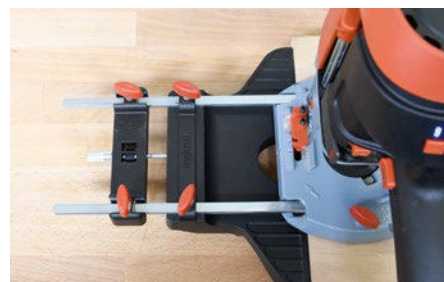
Der mitgelieferte Parallelanschlag mit Feinjustierung verrichtet seine Arbeit zufriedenstellend, ist aber auch wirklich nur auf seine Grundfunktionen beschränkt.
