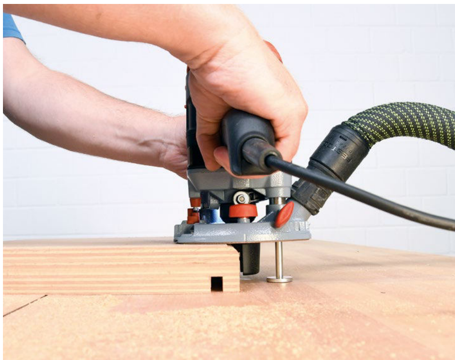
Hilfreich, aber auch bei anderen Maschinen vorhanden: Der ausklappbare Fuß gibt Stabilität beim Fräsen von Kanten.
