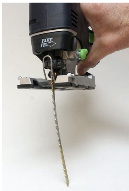
Hier wurde ein sehr langes Sägeblatt eingebaut. Man kann damit gut dessen Biegefähigkeit demonstrieren.
