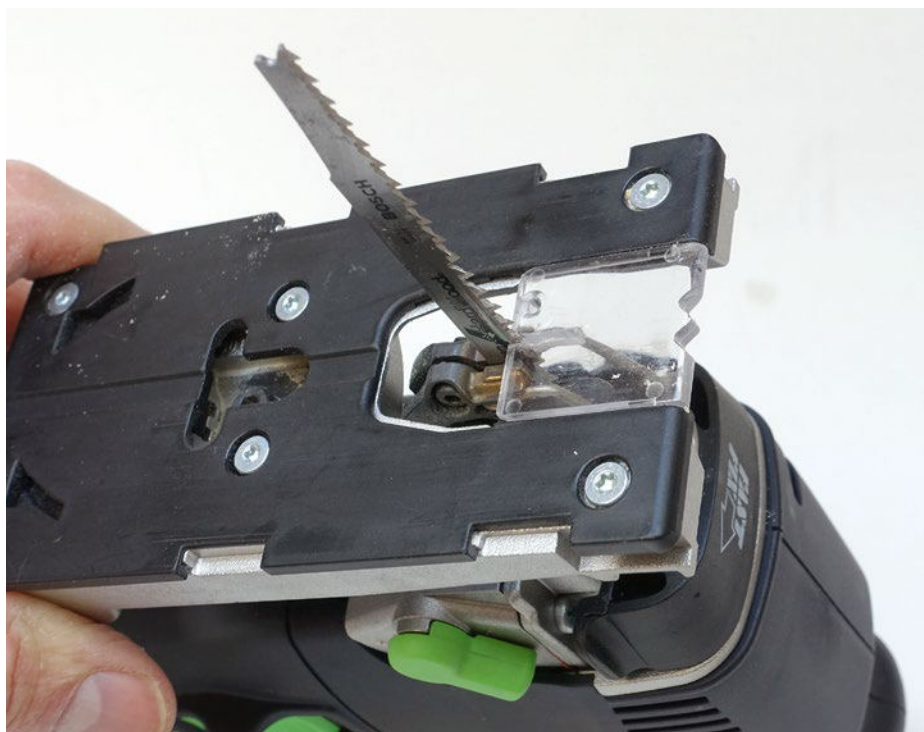
Ein spezielles Acrylplättchen wirkt Wunder: auch bei etwas größeren Sägeblättern bekommt man damit ausrissfreie Schnittkanten.
