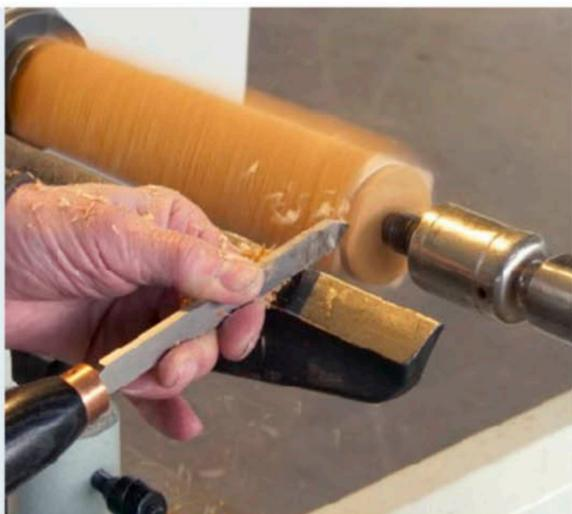
**1** | Mittig zwischen den Spitzen eingespannt, bekommt der Rohling zunächst einen Zapfen zum Einspannen in Ihr Spannfutter. Hier beträgt der Durchmesser 50 mm.
