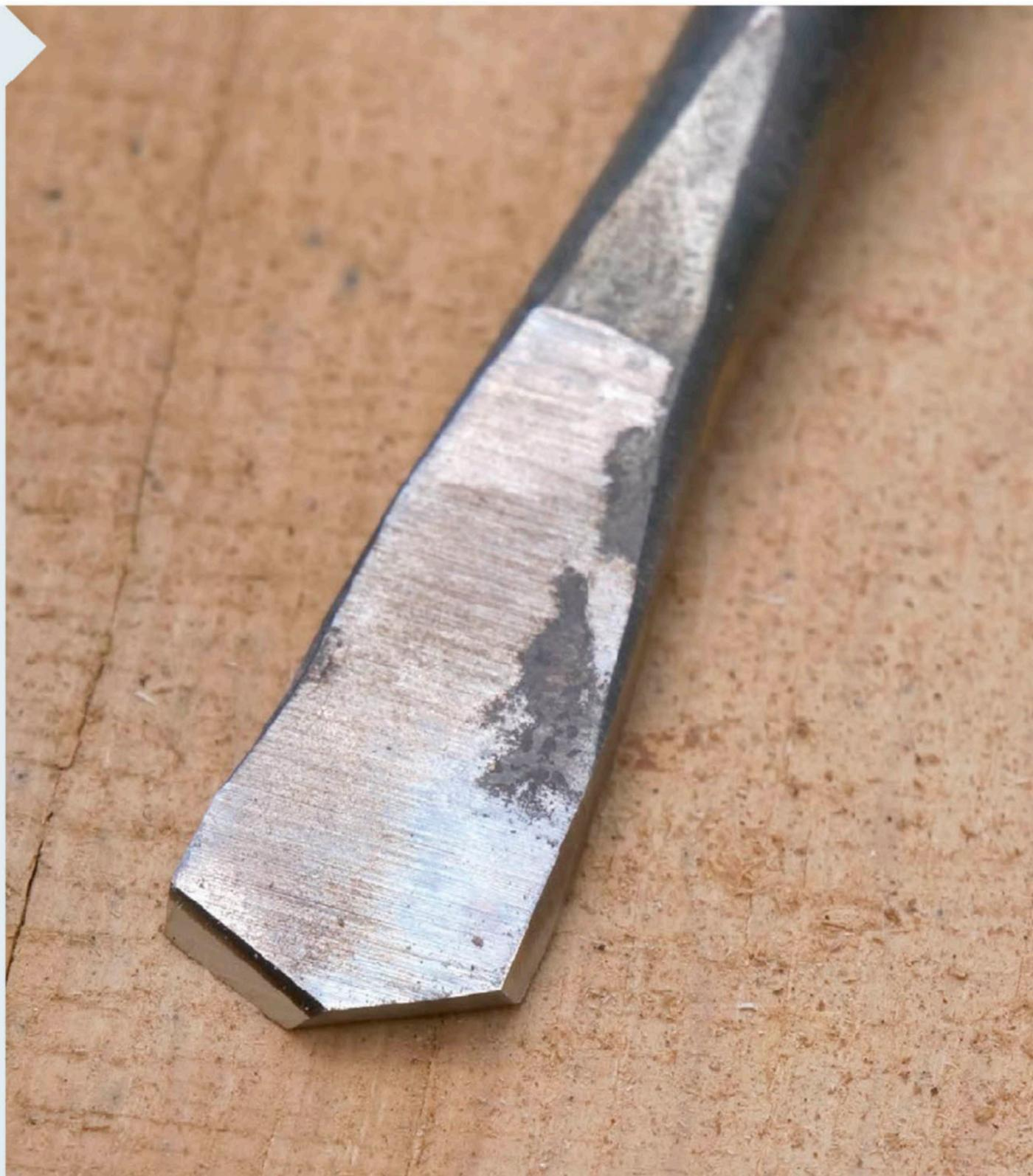
**3** | Um noch tiefer zu bohren, kommt statt einer Verlängerung dieser Eigenbau zum Einsatz: Der Stahl wird vorne flach ausgeschmiedet, dann auf 120° hergerichtet und an beiden Schneidkanten auf etwa 30° angeschliffen.
