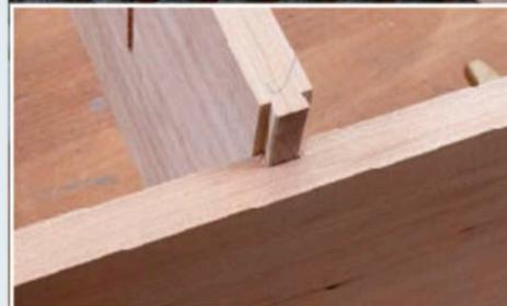
**10** | Es genügt, wenn die sich die Feder etwa 2 cm in ihre Nut schieben lässt. Etwas Kantenbrechen mit dem Hobel und „Fusselentfernen“ mit Schleifpapier wirkt meist schon Wunder für die vollständige Passung. Kleine Haken an jeder passenden Verbindung erleichtern den Überblick.
