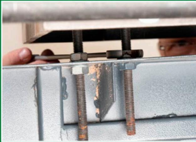
Drehen Sie dann besagte, als Anschlag dienende Schraube von Hand stramm unter den Tisch. Mit zwei Schraubenschlüsseln kontern Sie die Verbindung. Auf dem Schraubenkopf legt sich der Tisch jedes Mal exakt in der richtigen Position ab, wenn er aus der geschwenkten Lage zurückkehrt.
