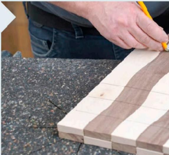
**7** Ähnlich wie in Längsrichtung reißen Sie nun alle 50 mm quer zum Faserverlauf eine Hilfslinie an.
