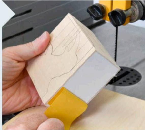
**5** Ist alles angezeichnet, geht es an die Säge. Damit Sie dem Sägeblatt nicht zu nahekommen, kleben Sie den Klotz mit doppelseitigem Klebeband zum Führen auf eine Platte.
