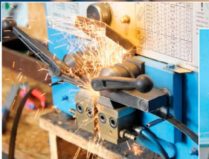
Hier verbindet der Schweißautomat die beiden exakt auf Maß gekappten Enden des Bandes.
