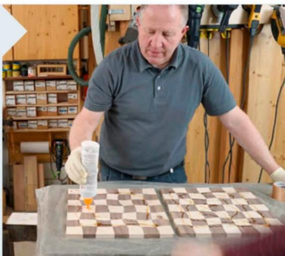
**12** | Zum Aufdoppeln kommt ein PU-Leim zum Einsatz. In der Mitte berühren keine Lebensmittel den Leim. In Sachen Standfähigkeit bei Flächenverleimungen ist PU-Leim ein Garant.
