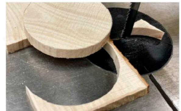
Größere Radien und vor allem Längsschnitte können mit einem solche Band (8 x 0,45 mm mit 6 ZpZ) gut bearbeitet werden.
