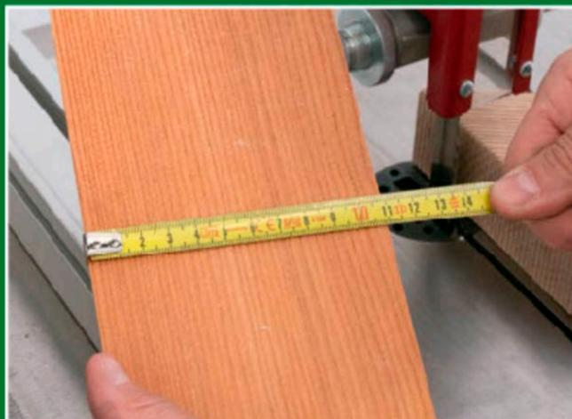
Wenn nicht, können Sie in der Regel leichte Korrekturen an der Befestigung des Anschlags vornehmen. Wenn der Fehler größer ist, nehmen Sie sich die Tischausrichtung noch einmal vor (Schritt 1).
