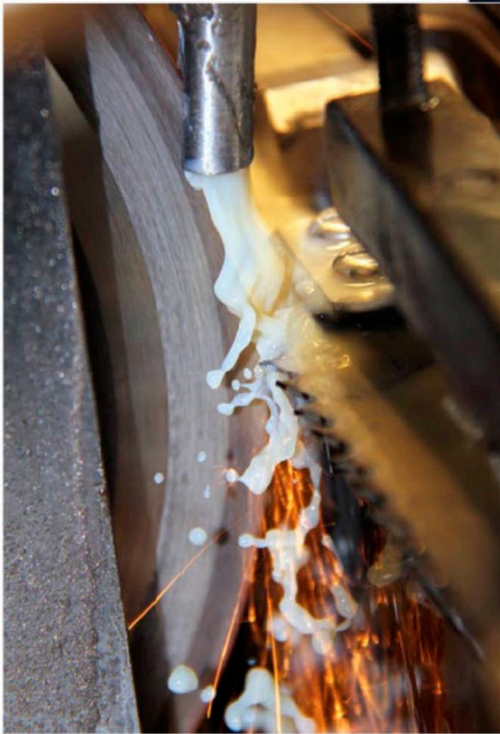
Eine von mehreren CNC-gesteuerten Schärfanlagen schleift die Sägebänder nass. (Für die Aufnahmen wurde der Kühlwasserstrom reduziert.) Der Vorschub und die weiteren Parameter werden nach der Ersteinstellung automatisch gesteuert.
