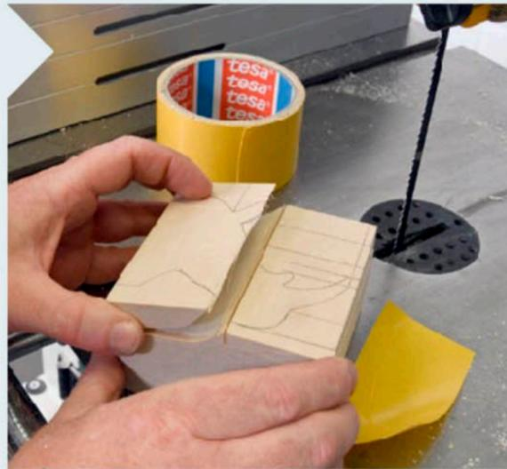
**7** ...und kleben Sie anschließend alles wieder vollflächig an. Der Klotz bekommt so wieder nahezu seine Ursprungsform.
