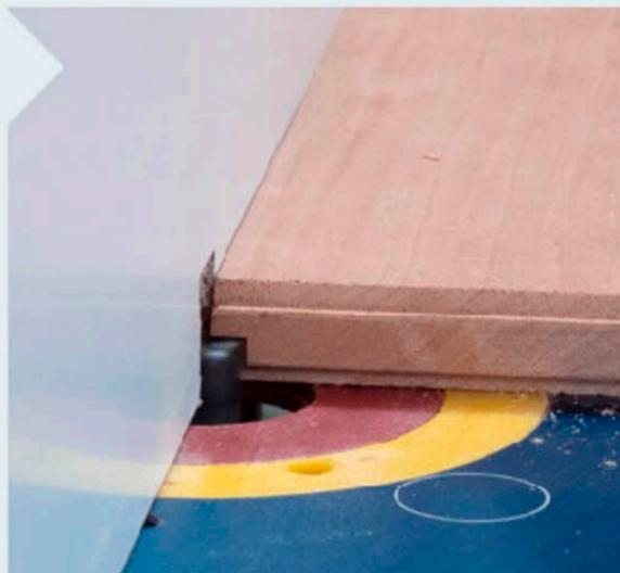
**13** | Ein mittelgroßer Nutfräser (hier: 14 mm Durchmesser) legt zunächst den Rückwand-Falz in den äußeren Seiten an. Er nimmt mit 8 mm Höhe mehr als die Dicke des Holzes ein, er reicht 5 mm weit in die Fläche.
