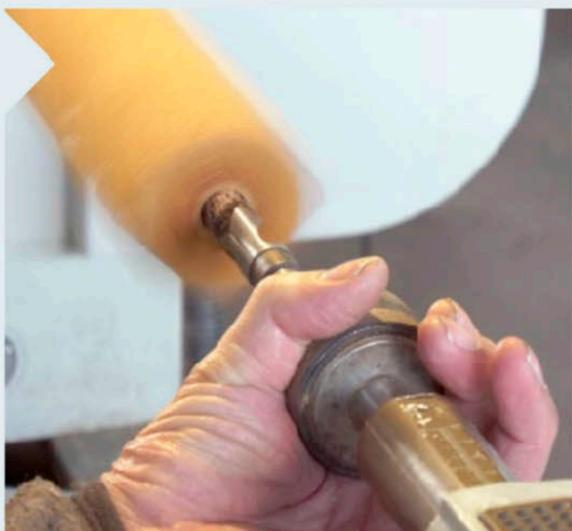
**2** | Zum Ausrichten dient noch die Körnerspitze, die dann durch das Bohrfutter ersetzt wird. Der 17-mm-Bohrer wird soweit eingebohrt, wie es geht. Ziehen Sie ihn dabei immer wieder heraus, um Späne zu entfernen.
