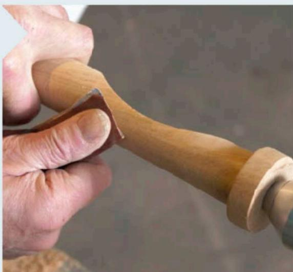
**13** | Schleifen Sie im Bereich der Hohlkehle von Hand bei stehender Maschine. Ansonsten ist die Wahrscheinlichkeit groß, dass die Kanten verrundet werden. Knackscharfe Kanten sind aber ein wichtiges Gestaltungselement des Blumenhalters!
