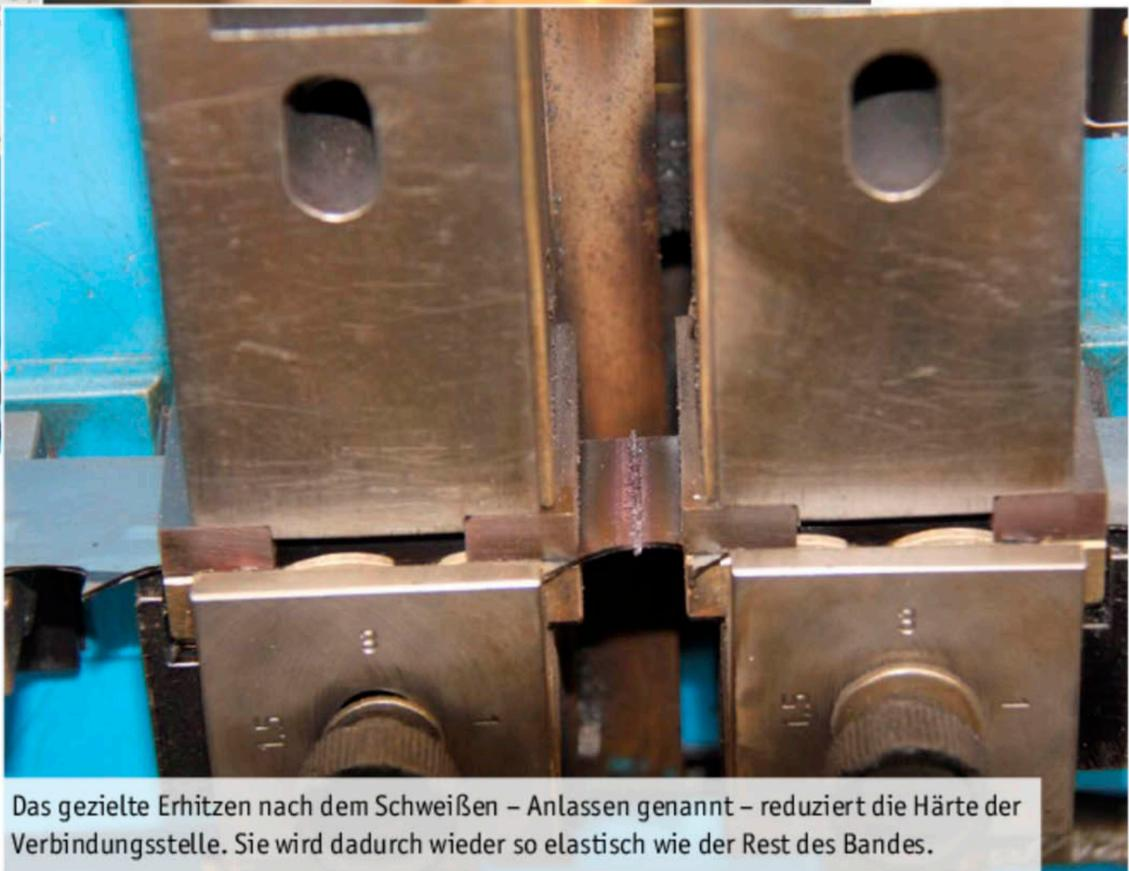
Das gezielte Erhitzen nach dem Schweißen – Anlassen genannt – reduziert die Härte der Verbindungsstelle. Sie wird dadurch wieder so elastisch wie der Rest des Bandes.
