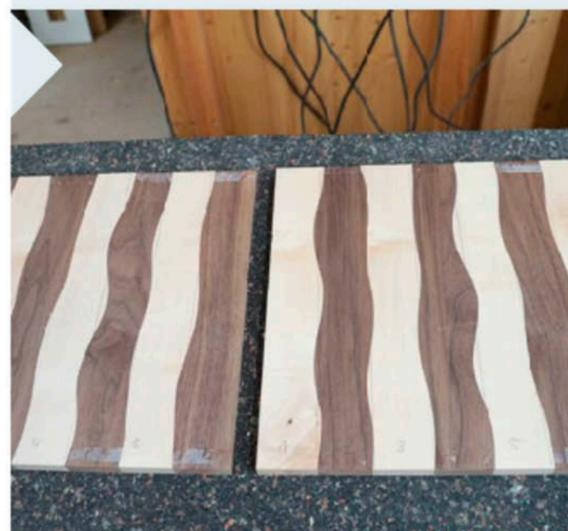
**3** Wenn Sie die mit Klebeband verbundenen Einzelteile nach dem Sägen der Leisten getrennt haben, ordnen Sie sie nun wechselseitig von unten nach oben an. Reihe zwei, vier und sechs tauschen ihre Plätze von unten nach oben, Ahorn und Nussbaum abwechselnd.
