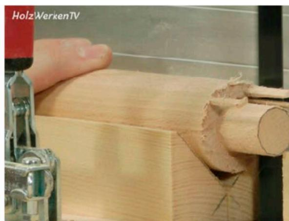
Eine gute **Vorrichtung** ist für die meisten Arbeiten in der Werkstatt der Schlüssel zum Erfolg. So auch beim Schneiden von **Dreikantleisten** und **Rundzapfen**.
