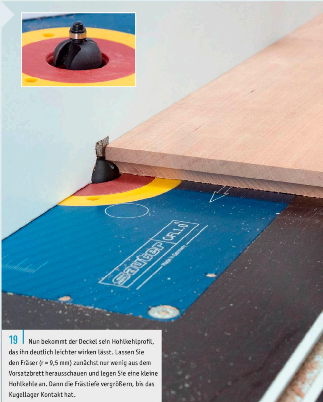
**19** Nun bekommt der Deckel sein Hohlkehlpprofil, das ihn deutlich leichter wirken lässt. Lassen Sie den Fräser ( $r = 9,5$  mm) zunächst nur wenig aus dem Vorsatzbrett herauschauen und legen Sie eine kleine Hohlkehle an. Dann die Frästiefe vergrößern, bis das Kugellager Kontakt hat.
