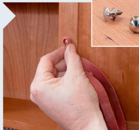
**29** Die kleinen Messing-Knöpfe waren Fundstücke beim Trödler. Eine Zange würde sie beim Eindrehen beschädigen. Mit einem stramm herumgezogenen breiten Gummiband lassen sie sich gut und fingerschonend eindrehen.
