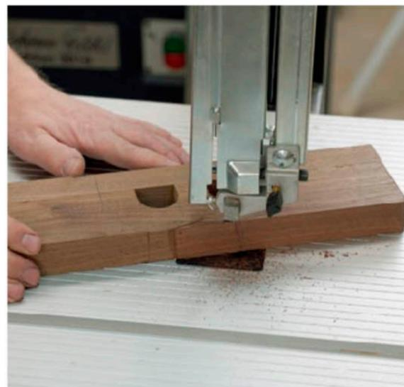
Mit einem zehn Millimeter breiten Sägeblatt wird das Mittelteil der Kontur des Buchstaben ausgesägt. Langsames Einsägen von außen zur Mitte hin garantiert ein gutes Schnittergebnis.
