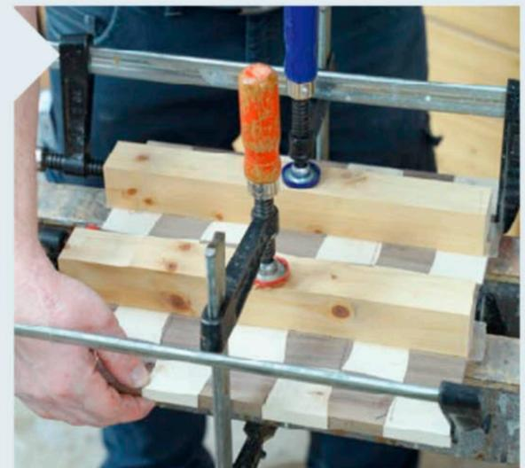
**11** Achten Sie unbedingt auf eine genaue Positionierung der Einzelteile. Durch zu viel Druck könnten diese im Faserverlauf reißen. Überprüfen Sie den Überstand: Alle Flächen müssen bündig sein.
