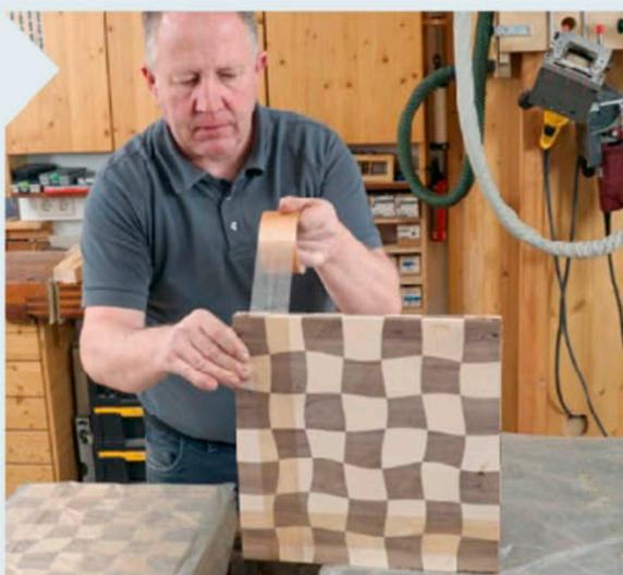
**13** | Sichern Sie alle vier Seiten mit Klebeband gegen ein mögliches Verrutschen beim Pressen.
