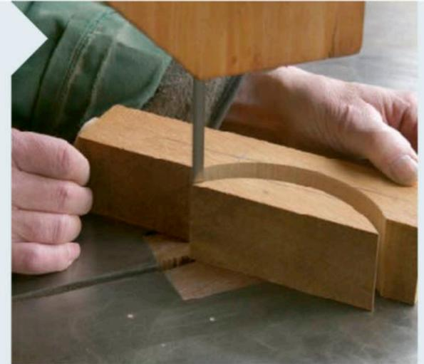
**6** Schneiden Sie den Bogen nun an der Bandsäge aus. Dabei wird die Bohrung geöffnet, was man beim Sägen in der Regel gar nicht bemerkt.
