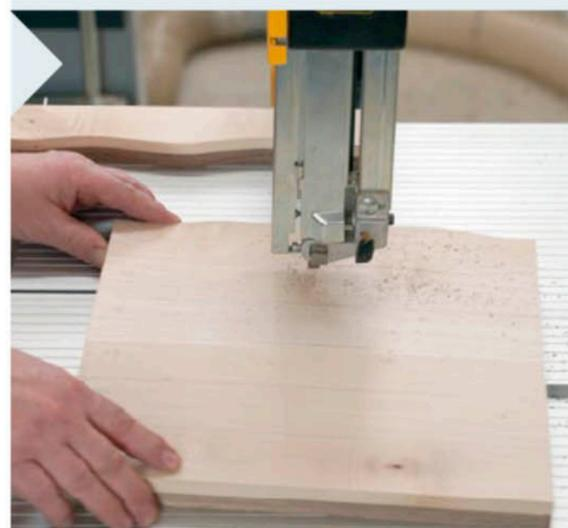
**2** Ziehen Sie alle 50 mm mit dem Bleistift eine Hilfslinie. Geschwungene Sägeschnitte machen den besonderen Reiz dieser Schneidebretter aus. Nummerieren Sie nach dem Sägen die Leisten entsprechend ihrer Reihenfolge.
