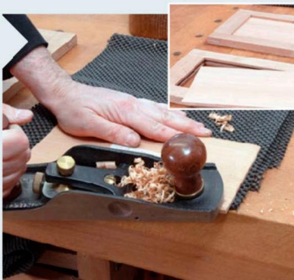
**24** Wenn alle Schlitzze und Zapfen gut zueinander passen, hobeln Sie die Füllungen auf etwas über 5 mm aus und schneiden sie auf Maß. Ein scharfer Putzhobel, leicht schräg gekippt, reduziert die Füllungsstärke an den Kanten auf exakt auf das Maß der Tür-Nut.
