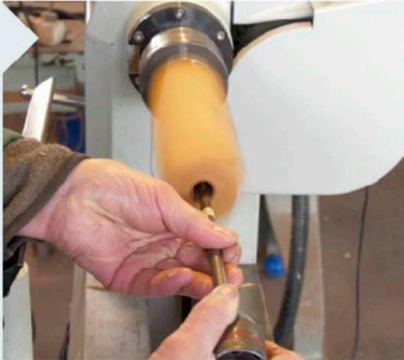
**4** Bei niedriger Drehzahl von nur 700 U/min kommt nun der Eigenbau in die Bohrung, um die letzten vier bis fünf Zentimeter Tiefe zu schaffen. Der hinten mit einem Handgriff versehene Bohrer zentriert sich dabei selbst.
