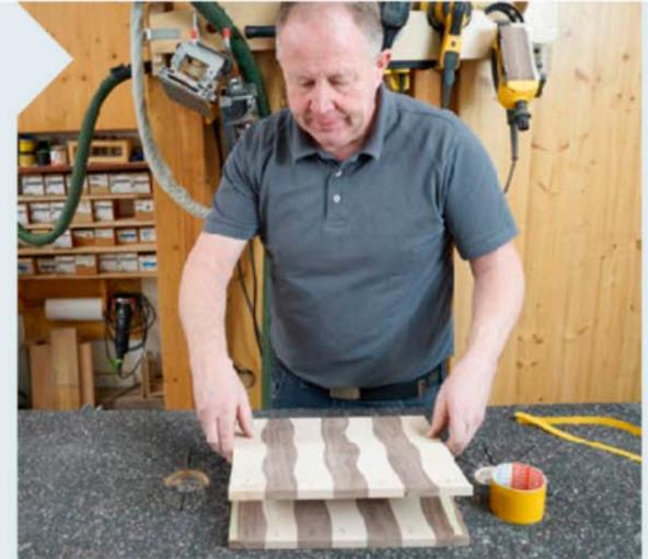
**6** Mit doppelseitigem Klebeband fixieren Sie die Platten längs zum Faserverlauf.
