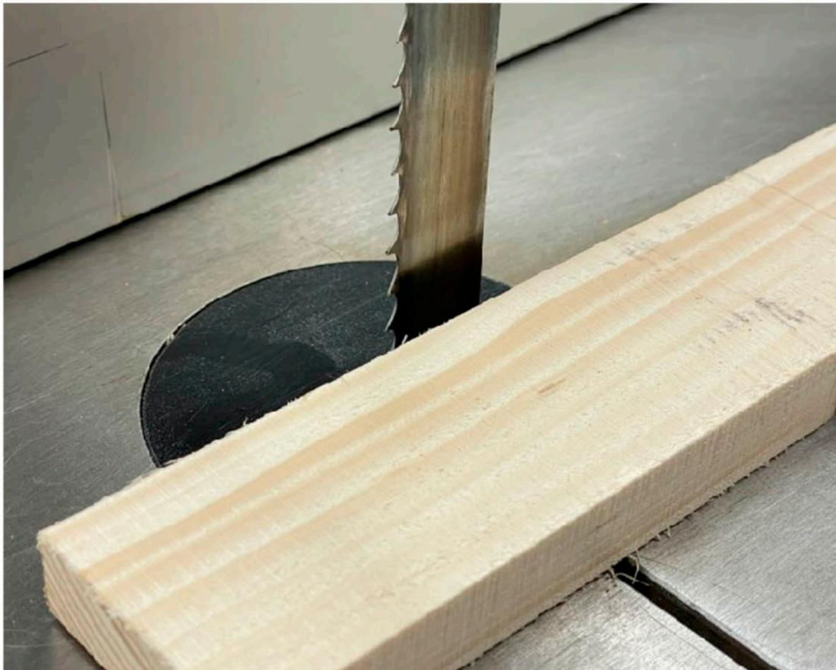
Längsschnitte in stärkerem Holz brauchen breitere Bänder und weniger Zähne. Hier ist es eine Hardback-Ausführung mit 20 mm Bandbreite, 0,65 mm und 4 ZpZ.
