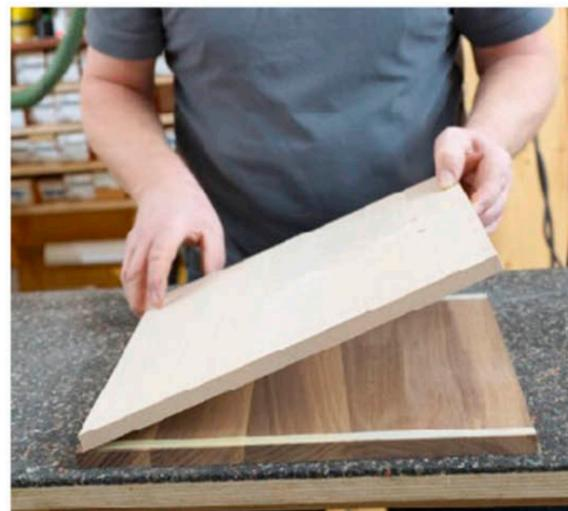
**1** Fixieren Sie für den ersten Einschnitt die Flächen in Längsrichtung mit doppelseitigem Klebeband aufeinander. Nummerieren Sie auch die beim Sägen entstehenden Leisten.
