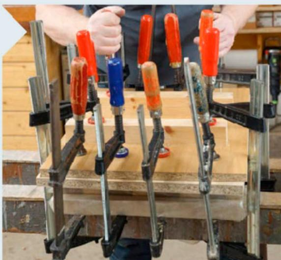
**14** | Trennschichten aus Folie verhindern das Anhaften der Flächen. Zulagen verteilen den Pressdruck der Schraubzwingen gleichmäßig auf der Fläche.
