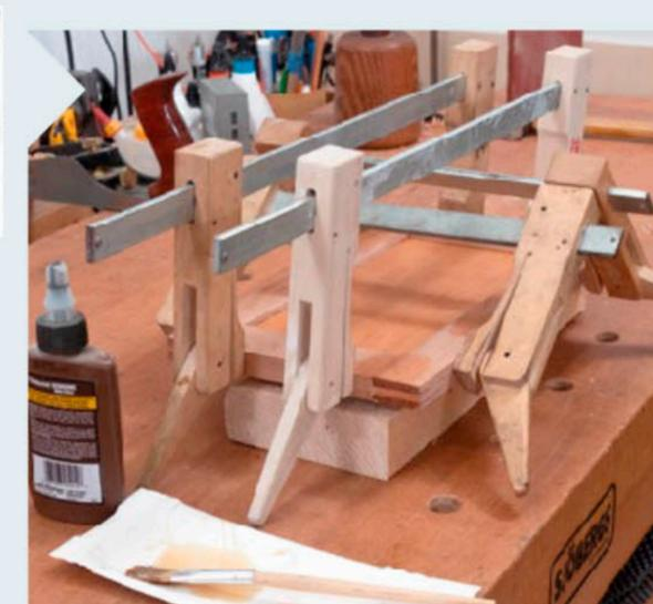
**25** Schleifen Sie die Füllungen bis Körnung 180 und behandeln Sie sie rundum zweimal mit Schellack. Dann können Sie die Türen verleimen. Die Nuten und Füllungen bekommen keinen Leim, nur Schlitzze und Zapfen. Klemmzwingen genügen für diese kleinen Türen völlig.
