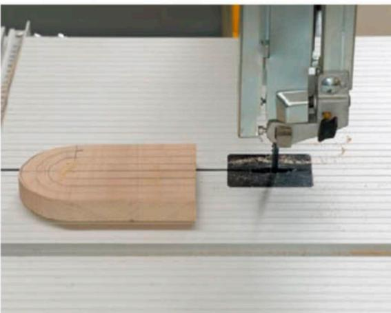
Mit dem Wechsel auf das 6-mm-Sägeblatt zeichnen sich die ersten Verläufe ab. Trotz eines geringen Vorschubs kommt es zu Einbußen in der Schnittqualität.
