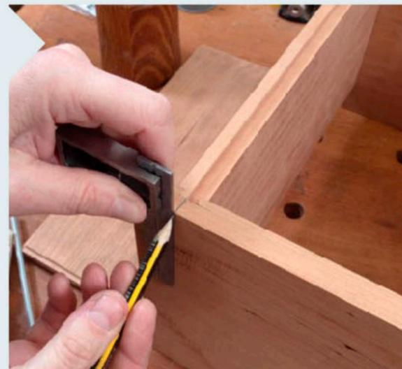
**14** | Stecken Sie den Korpus (Pos. 1 bis 4) zum ersten Mal vollständig zusammen. Jetzt können Sie anzeichnen, wie weit Boden und Deckel zu Aufnahme der Rückwand gefälzt werden müssen.
