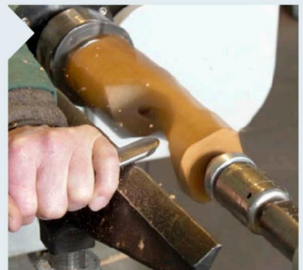
**9** Bei jeder Umdrehung kommt der Hohlraum vorbei. Üben Sie in Richtung des Werkstücks fast keine Kraft aus und stellen Sie sicher, dass die Röhrenfase auch bei der Wiederkehr des Holzes sofort wieder anliegt.
