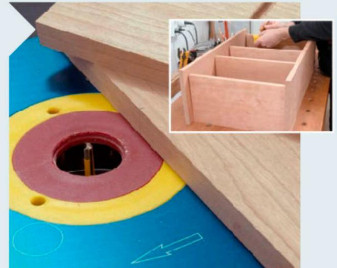
**3** Schneiden Sie die vier Seiten zunächst auf 170 mm Breite. Deckel und Boden bekommen zunächst beide eine Breite von 195 mm. So reichen die Gratnuten von hinten gesehen gleich weit ins Material. Der Boden wird erst später auf seine Breite von 185 mm gebracht.
