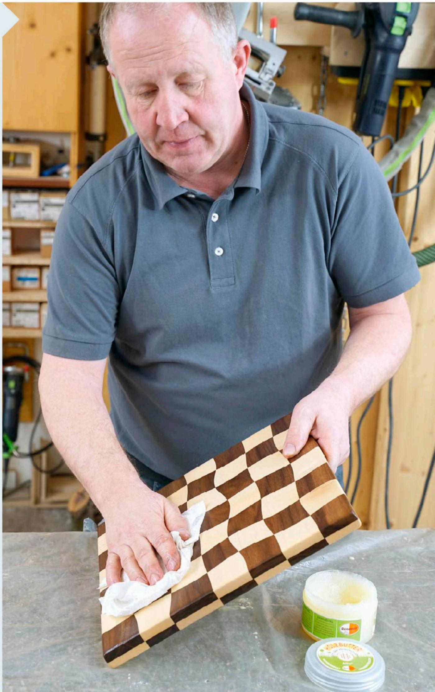
**15** | Mit Holzbutters werden die Oberflächen behandelt. Die Butters wird mit den Händen auf der Oberfläche verrieben. Körperwärme verteilt das Material auf der Oberfläche. Überschüsse nehmen Sie mit einem weichen Tuch ab.
