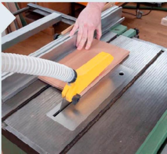
**11** | Beachten Sie beim Schneiden auf Breite, dass die Außenseiten vorne um 3 mm weniger weit vorstehen als die Innenseiten (wegen des Scharnierbands), die Innenseiten aber hinten um 5 mm vorspringen (Rückwand-Falz). So entstehen die in der Tabelle angegebenen Breiten.
