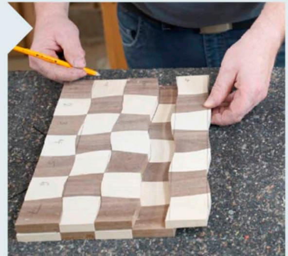
**9** Sobald das Klebeband entfernt wurde, ordnen Sie die entstandenen Leisten wechselseitig von unten nach oben vertauscht an. So erhält man das einzigartige Bild der Oberfläche.
