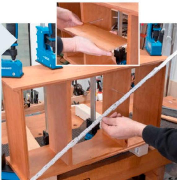
**21** Die nicht allzu stramm gearbeiteten Gratfedern können etwas Leim und Zwingendruck vertragen, wenn der Korpus zusammenkommt. Die beiden Diagonalen müssen identisch sein. Ist der Leim getrocknet, passen Sie den Zwischenboden ein.
