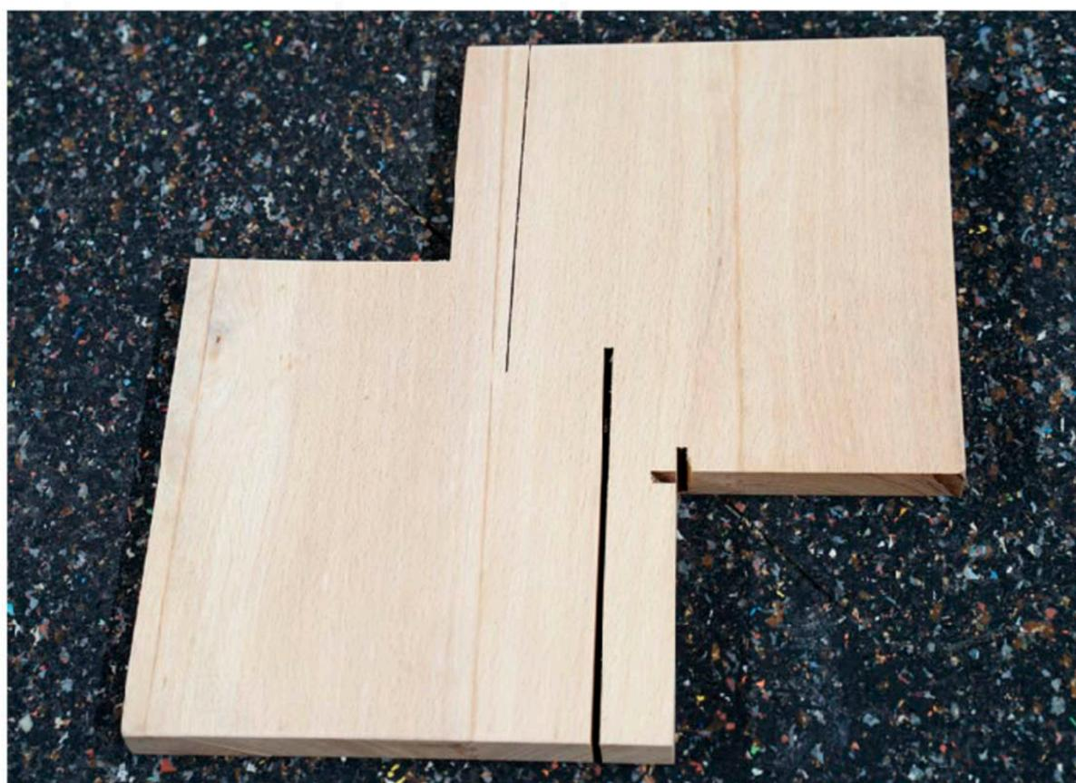
Aus- und Einschnitte lassen sich mit der Bandsäge sauber umsetzen. Unterschneiden, wie es beim Sägen mit der Kreissäge unvermeidbar ist, ist mit der Bandsäge kein Thema.
