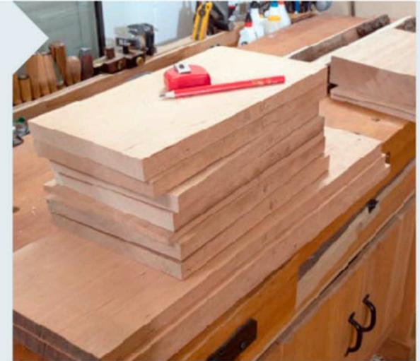
**1** Zwei Bohlenabschnitte von 62 mm Dicke sind hier der Ausgangspunkt. Aus ihnen werden an der Bandsäge Schnitt für Schnitt die nötigen Teile herausgeholt. Arbeiten Sie unbedingt wie hier mit einer Zuführlade für den Druck an den Anschlag und den Vorschub.
