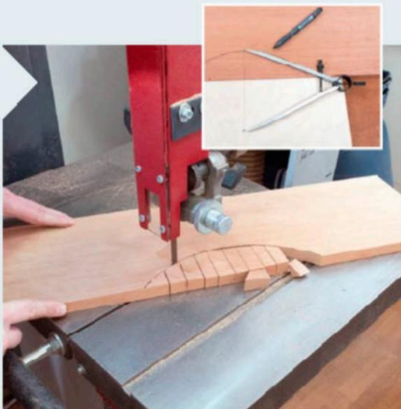
**18** Der Boden bekommt jetzt seine markante Einbuchtung. Mittig, der Mittelpunkt 88 mm von der Vorderkante entfernt und mit einem Radius von 146 mm. Schleifen Sie den Bogen dann mit einem möglichst dicken Rundstab, um den Sie Schleifpapier wickeln.
