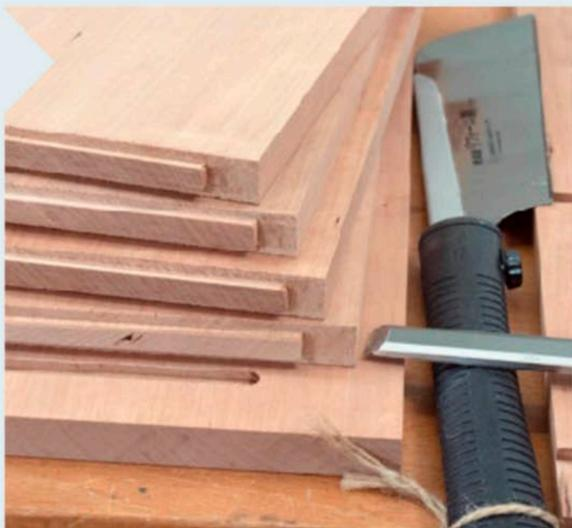
**12** | Mit Japansäge und Stechbeitel sind die Bereiche der Gratfeder, die über die Nut-Enden überstehen, abgesetzt. Halten Sie dafür jede Feder an „ihre“ Nut und zeichnen Sie den abzusetzenden Bereich an.
