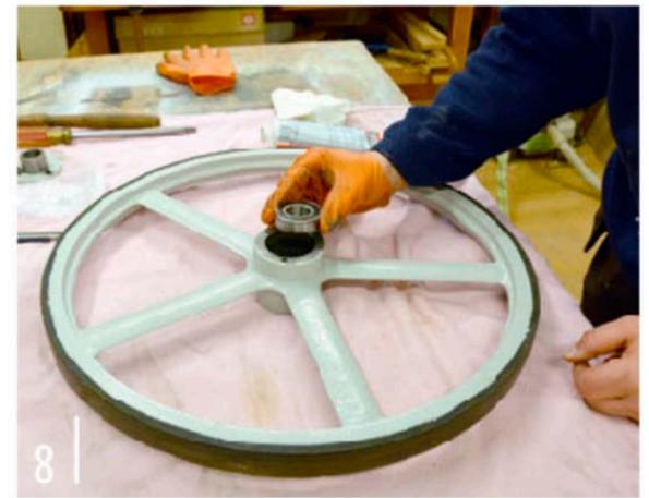
In umgekehrter Reihenfolge wird die Bandsäge wieder zusammengebaut. Wer es so weit geschafft hat, kommt zum angenehmeren Teil einer Restaurierung – es ist eine Freude zu sehen, wie sich die Maschine wieder zusammenfügt (Bild 9).
