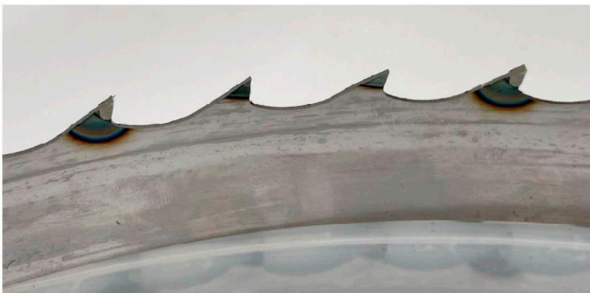
Zahnsitzen aus der Hartlegierung Stellite werden wie hier zu sehen auf den Band-Körper aufgeschweißt oder -gelötet.
