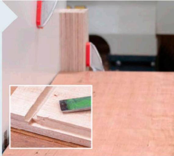
**16** Befestigen Sie rechts vom Werkstück einen Klotz als Rückschlagsicherung. Fräsen Sie dann zwischen den Bereichen, die auf Boden und Deckel für den Falz angezeichnet sind. Halten Sie etwas Abstand dazu. Den Rest nehmen Sie per Stecheisen aus.
