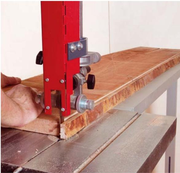
An der Bandsäge (mit Tischverlängerung) wird auch frei Hand nach Anriss besäumt, wenn keine passende Kreissäge zur Verfügung steht.
