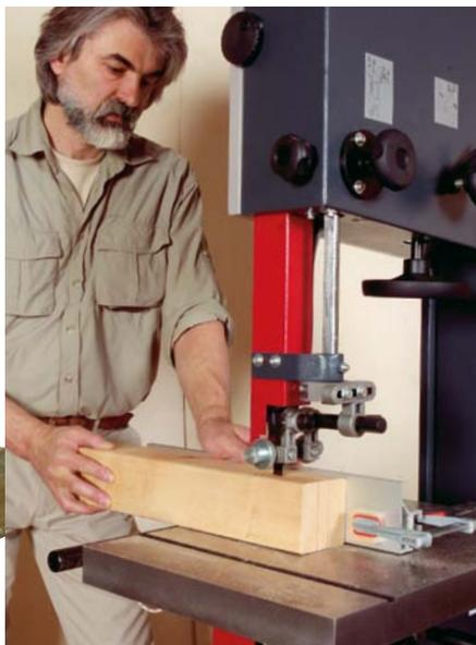
*Kleine Kniffe erhöhen die Möglichkeiten der Bandsäge noch: Ein angeklemmter Klotz dient hier als Schnittlängenbegrenzer.*
