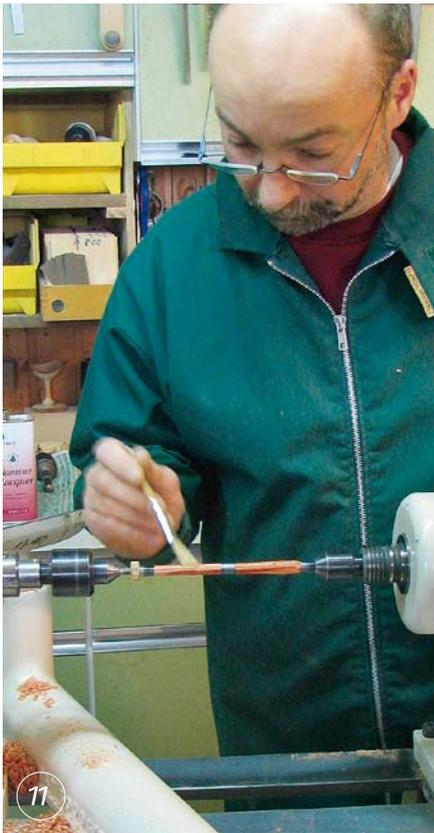
11 *Der Lack wird mit einem Pinsel aufgetragen, den Überschuss längs mit einem Baumwolltuch abgenommen. Nach jeweiligem Zwischenschliff mit feinsten Stahlwolle wird dieser Vorgang ein- bis zweimal wiederholt und abschließend mit einem Baumwolltuch bei laufender Bank poliert.*
