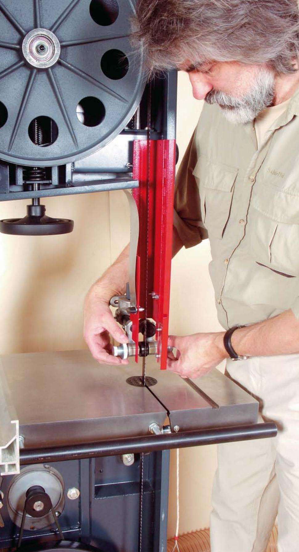
*Die Rollenführung muss bei jedem Sägeblattwechsel exakt eingestellt werden. Die Rollen sollten das Band im Leerlauf nicht berühren.*
