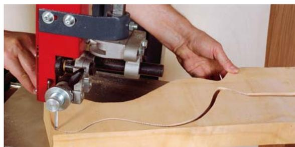
tet sein. Die obere Bandführung ist vertikal auf die Werkstückhöhe verstellbar.
