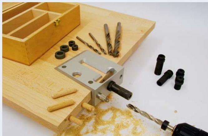
*Der Alu-Winkel als Kernstück des Dübelo-Sets sorgt mit einer eingeschraubten Hülse für die exakte Führung des Bohrers in Flächen, Gehrungen und Schmalflächen. Für immer gleichen Abstand sorgt ein eingesteckter Kopierdorn.*
