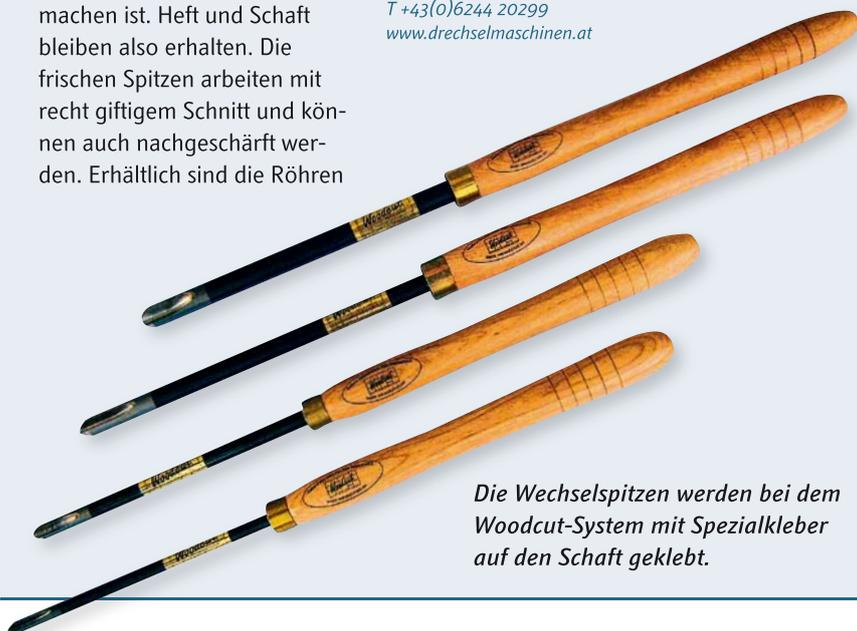
*Die Wechselspitzen werden bei dem Woodcut-System mit Spezialkleber auf den Schaft geklebt.*
