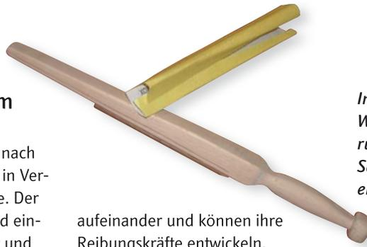
*In das längs geschlitzte Werkzeug wird das rundum geschlagene Schleifpapier einfach eingeklemmt.*
