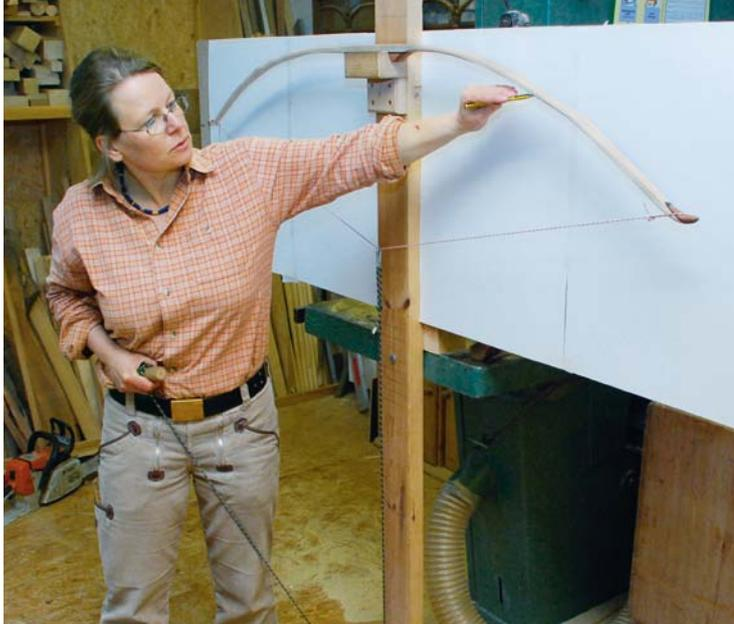
Auf dem „Tillerbrett“ wird der Bogen zum ersten Mal gespannt. Beide Wurfarme müssen sich exakt gleich beugen. Der Vorgang wird dutzende Male wiederholt, dazwischen wird das Holz weiter bearbeitet.
