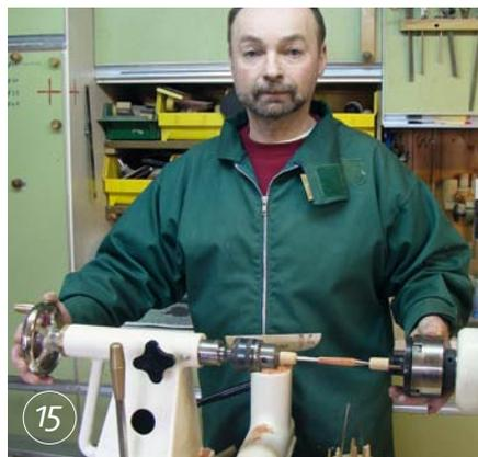
13 *Zwischen den beiden Hilfshölzern werden die Spitze und Mechanik in das Unterteil eingepresst. Den Pressvorgang können Sie mit dem Handrad am Reitstock sehr fein dosieren.*
