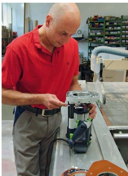
*Der Spindelstopp mit Wippe und Ratschentechnik macht einen schnellen und sicheren Fräserwechsel möglich – ohne Umsetzen des Schlüssels.*
