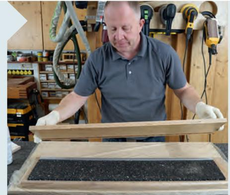
**6** | Legen Sie das Mittelteil auf die erste Lage mit der Bautenschutz-Matte auf. Achten Sie darauf, dass alles bündig liegt. Auch wenn eine Verschnittzugabe eingeplant ist, kann zu viel Verlust beim späteren Zuschnitt den Anschlag zu klein werden lassen.
