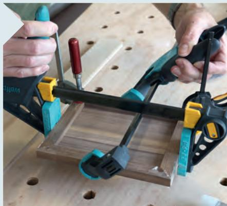
**10** Damit die Verleimung des Türrahmens unter ausreichend Druck erfolgt, bringen Sie Zwingen an der Längs- und Kopfseite an. Die Türfüllung darf in der Nut nicht eingeleimt werden. Sie kann sonst nicht quellen und schwinden und könnte dadurch reißen.
