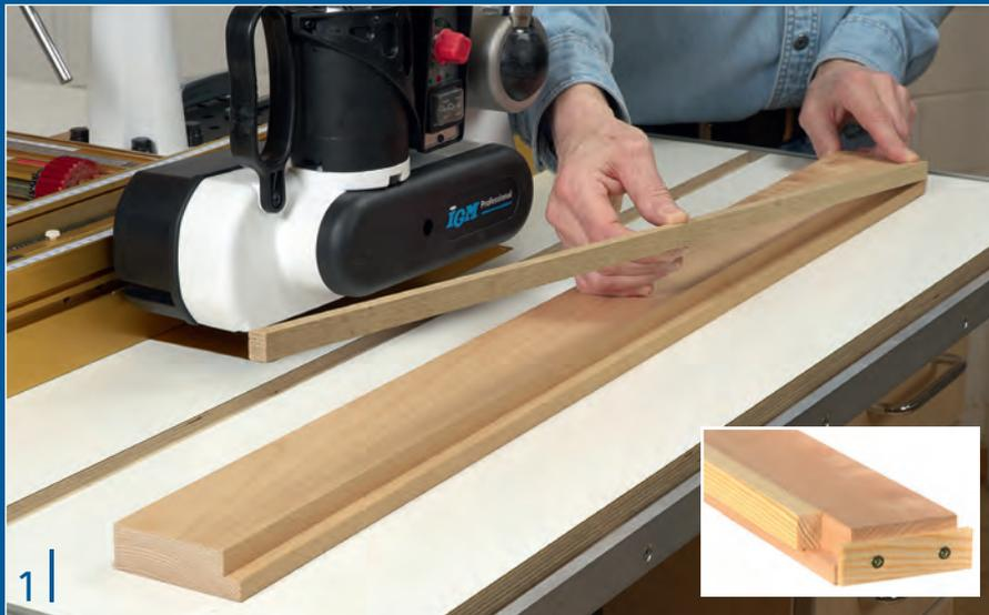
Legen Sie die Leiste in den Falz des Führungsbretts ein. Damit die Leiste am hinteren Ende nicht rausrutscht, schrauben Sie ein dünnes Stoppbrettchen auf (im kleinen Bild zu sehen).
