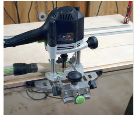
1 | Am Seitenanschlag lässt sich die Oberfräse beim Fräsen der Schienennut präzise führen. Zum Einsatz kommt ein 16-mm-Nutfräser. Die erforderliche Nutbreite von 17 mm für die T-Nuttschiene entsteht dann durch leichtes Verstellen des Anschlags.
