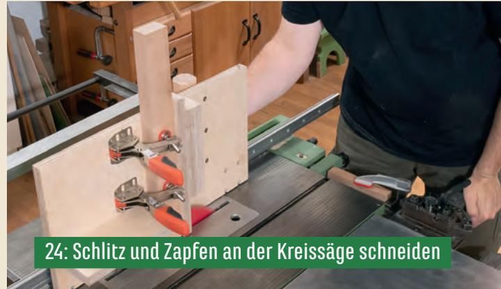
24: Schlitz und Zapfen an der Kreissäge schneiden
