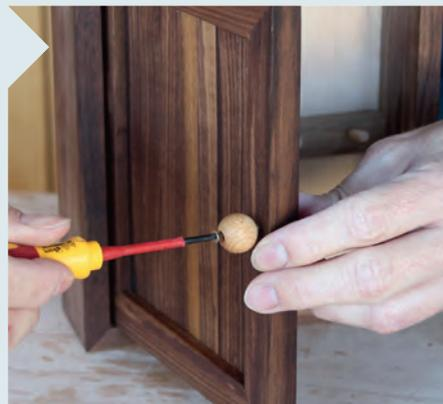
**22** Eine kleine Kugel ist der Griff, den Sie nun als Abschluss montieren können. Allerdings reicht zum Aufklappen der Tür auch die Kraft des Magneten. Und wo bewahren Sie nun den Magneten sicher auf?
