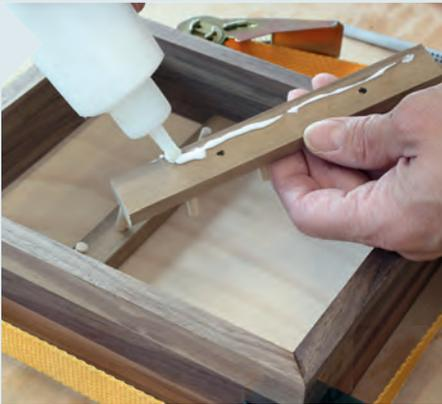
**19** Fixieren Sie den Korpus des Schlüsselkastens mit einem Ratschengurt. So kann der Leim ungestört abbinden. Währenddessen können Sie die Hakenleisten (Pos. 7) auf die Rückseite kleben.
