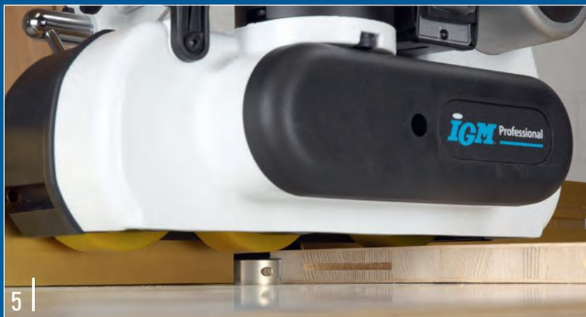
5 | Führen und halten Sie das Werkstück immer so lange dicht am Anschlag, bis es auch an der linken Anschlagfläche des Parallelanschlags angekommen ist. Sonst könnte es durch die Schrägstellung in die Anschlaglücke gedrückt werden.
