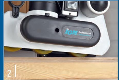
Den Vorschub heben Sie so weit an, dass nur noch die hintere Vorschubrolle Kontakt mit der Schablone hat. Um genügend Druck auf das Werkstück auszuüben, sollte die Rollenfläche etwa 3 mm unterhalb der Schablonenoberfläche liegen.
