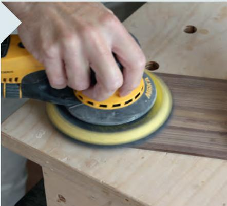
**7** Der Leim in der Füllung und in den vier Korpusteilen hat nun abgebunden. Lösen Sie die Bauteile aus ihrer Fixierung und entfernen Sie die überstehenden Leimreste mit einem Schleifer.
