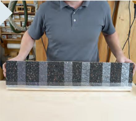
**4** | Anschließend nehmen Sie die mit Klebeband fixierte Außenseite ab und Sie können mit der Verleimung beginnen. Die beiden mit 8 mm gleich dick ausgeführten Außenseiten garantieren eine sehr hohe Präzision und Aussteifung des Anschlags.
