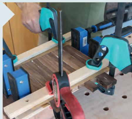
**4** Für die Türfüllung (Pos. 6) sägen, fügen und schleifen Sie die einzelnen Leisten. Verleimen Sie diese mit Zulagen und Zwingen. Diese setzen Sie von der Seite und von oben an. Danach stellen Sie auf gleiche Weise die Teile für den Korpus her.
