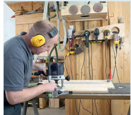
2 | Eine längere Platte (hier der Tisch) unterhalb des bündig daran angelegten Werkstückes dient als Führungshilfe. So wird das ungewollte Verlaufen am Werkstückende vermieden, wenn der Anschlag am eigentlichen Werkstück keinen Halt mehr hat.
