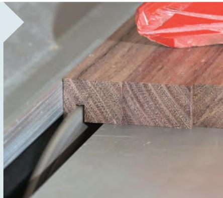
**13** Das Nuten der Korpusteile für die Rückwand steht an. Das erledigt die Tischkreissäge spielend. Außerdem sägen Sie nun auch die Gehrungen an die Korpusteile.
