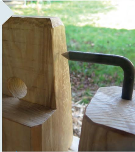
**17** Mit der eingeschlagenen Spitze können Sie am linken Reitstock die Bohrung für die zweite Spitze an und bohren rechtwinklig mit einem 14-mm-Bohrer 50 mm tief.
