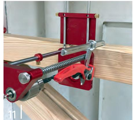
Querträger rechtwinklig zu den Längsträgern aus, und bohren Sie die Löcher für die Steckbolzen weiter in die Querträger. Nutzen Sie dabei die schon vorhandenen Löcher in den Bügeln als Bohrführung.
