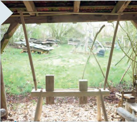
**10** | Aus zwei Viertelspaltlingen werden die aufrechten Arme für den Gummizug ausgearbeitet. Ans untere Ende wird ein runder, 38 mm starker, Zapfen geschitzt. Schlagen Sie die Arme ins Bett der Drehbank ein und längen Sie sie auf 140 cm über dem Bett ab.
