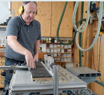
**10** | Achten Sie beim Breitenzuschnitt darauf, dass der Abstand zwischen der Profilschiene und dem Sägeschnitt genau zu Anforderungen Ihrer Maschine passt. Setzen Sie zum Sägen dieses Materialmixes ein Sägeblatt mit einer hohen Zähnezahl für Plattenwerkstoffe ein.
