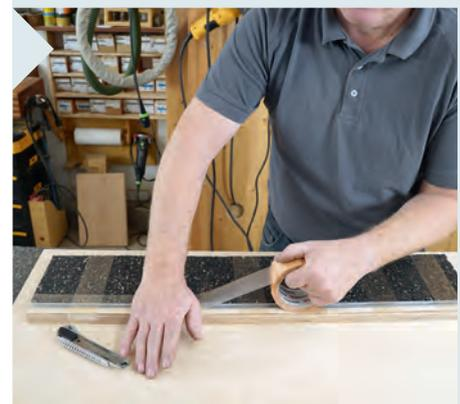
3 | Nach dem Einlegen der Schiene in die 4 mm tief gefräste Nut werden die Einzelteile zusammengelegt und mit Klebeband überklebt.
