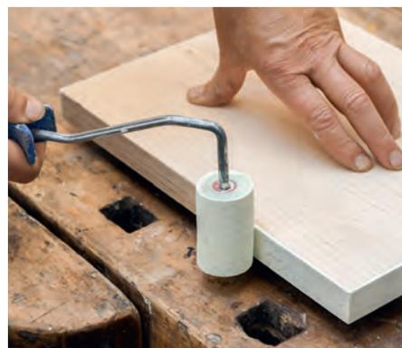
Erst die Kante, dann die Fläche abrollen. Wer Leisten unter das Werkstück legt, erleichtert sich den Farbauftrag mit der kleinen, kantigen Schaumstoffwalze.
