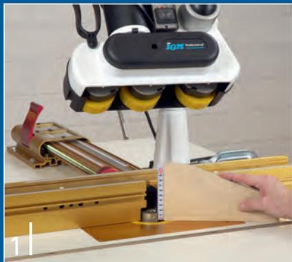
1 | Bevor Sie den Vorschubapparat positionieren können, müssen Sie die Fräserhöhe und -weite (also den Fräsanschlag) möglichst genau einstellen. Kleinere Korrekturen sind später auch mit abgesenktem Vorschub noch möglich.
