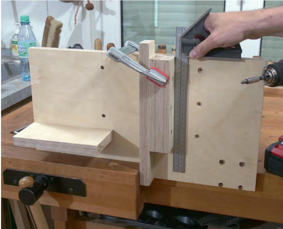
**5** Wenn alle Löcher im Grundbrett gebohrt sind, schrauben Sie das Schutzblech (links) an. Dann folgen Werkstückhalter, hier schon mit angeschraubtem Splitterklotz. Dieser Block dient der Werkstückanlage und muss genau winklig sitzen.
