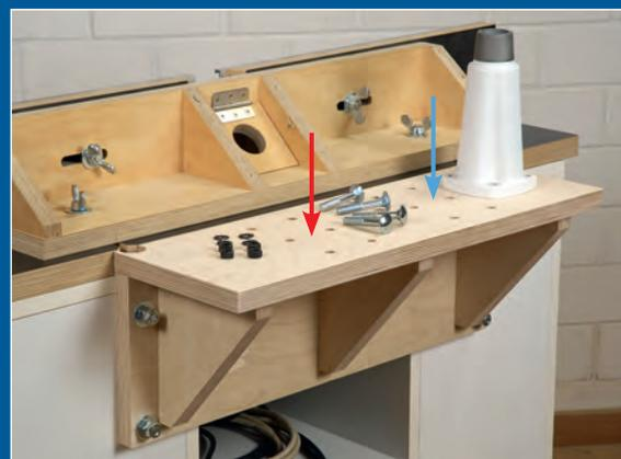
Damit Sie die Selbstbau-Konsole mit vier Schlossschrauben befestigen können, sollten die Unterschränke über mindestens 15 mm dicke Rückwände verfügen.
