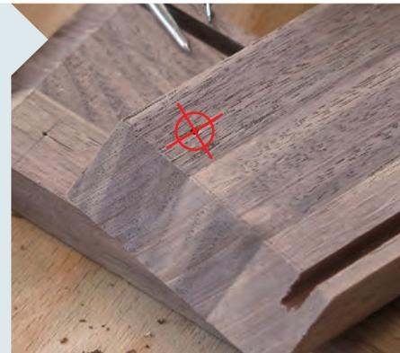
**14** Auf den Korpusteilen (Pos. 2 & 3) zeichnen Sie nun die Scharnierlöcher und das Bolzenloch ein. Das untere Scharnierloch (in Pos. 2) muss durchgängig gebohrt werden. Das Scharnierloch in Pos. 3 und das Bolzenloch in Pos. 2 werden als Sackloch gebohrt.
