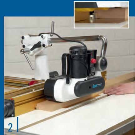
Jetzt schieben Sie Führungsbrett samt Leiste am Anschlag anliegend unter den Vorschub. Drücken und halten Sie beides noch so lange mit den Händen dicht an der rechten Anschlagbacke, bis es auch an der linken anliegt.
