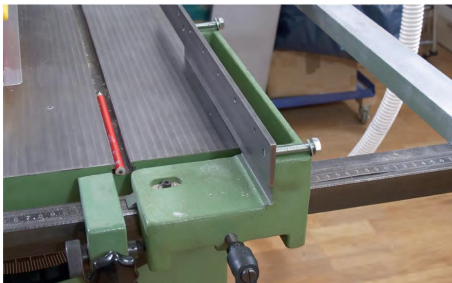
**1** Hier ist der Grundkörper des Parallelanschlages sein Anschlagline zu sehen. Vorbereitet ist statt dessen ein Zwischenstück aus Stahl, die hier mit zwei M8-Schrauben befestigt wird. Dessen Maße müssen Sie passend zu Ihrer Maschine wählen.
