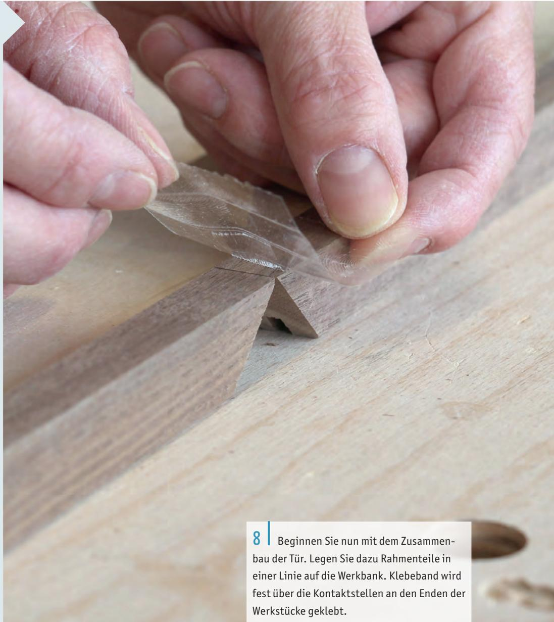
**8** Beginnen Sie nun mit dem Zusammenbau der Tür. Legen Sie dazu Rahmenteile in einer Linie auf die Werkbank. Klebeband wird fest über die Kontaktstellen an den Enden der Werkstücke geklebt.
