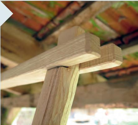
**11** | Dann können Sie die Zapfen und die offenen Zapfenlöcher ausarbeiten und die Spreizleiste einpassen. Unter ihr wird mit zwei kleinen Holznägeln als Stopp der Gummizug, der als Feder für das Fußpedal dient, befestigt.
