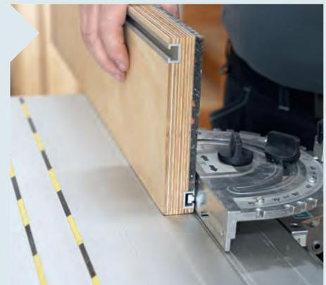
**12** | Achten Sie darauf, dass beim Materialmix aus Sperrholz, Schiene und Bautenschutz-Matte eine ebene Fläche entsteht. Nur so kann der Anschlag präzise im 90°-Winkel zum Maschinentisch gespannt werden. Ein Stück Furnier kann sonst beim Ausrichten helfen.
