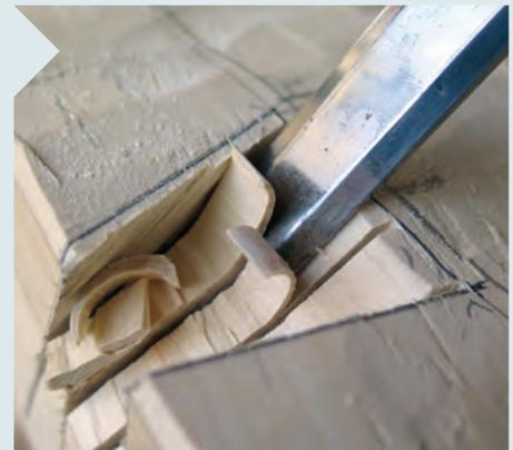
**6** Arbeiten Sie mit einem Stecheisen die Schwalben aus und passen Sie die Beine einzeln ein. Für die Feinanpassung können Sie die Zinken noch mit dem Hobel nachputzen.
