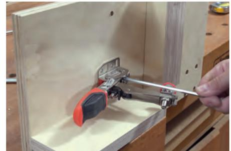
**7** Nutzen Sie das große Loch in der Grundplatte des Spanners, um die enormen Kräfte abzuleiten. Dazu dienen eine M6-Schraube und eine Einschlagmutter auf der anderen Seite.
