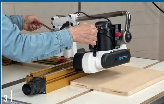
3 | Zum Einstellen legen Sie zuerst das Werkstück unter den Vorschub und senken ihn auf die Werkstückfläche ab. Bewegen Sie jetzt den Vorschub nach links oder rechts, bis sich der Fräser ungefähr zwischen der ersten und zweiten Vorschubrolle befindet.
