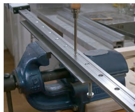
**2** Die Gleitschiene mit der DryLin-Technik von Igus lässt sich dann auf das Stahlstück schrauben. Wir empfehlen, die gelochte Schienenvariante zu beschaffen.
