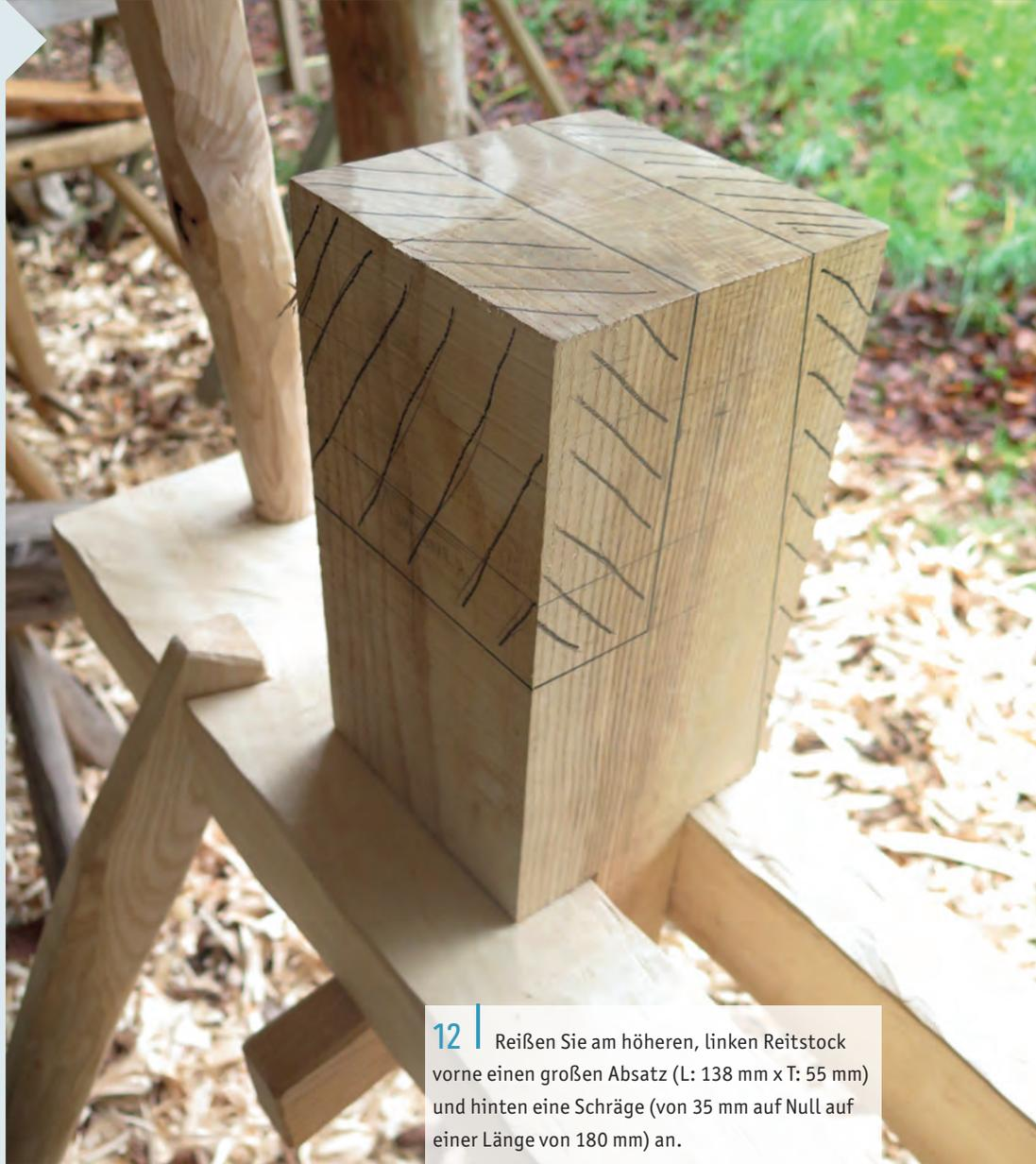
**12** | Reißen Sie am höheren, linken Reitstock vorne einen großen Absatz (L: 138 mm x T: 55 mm) und hinten eine Schräge (von 35 mm auf Null auf einer Länge von 180 mm) an.
