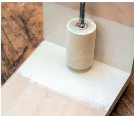
Walzen erreichen Innenkanten nicht vollständig. Es ist sinnvoll, diese Bereiche mit einem feinen, flachen Pinsel vorzubehandeln. Anschließend wird die Walze so geführt, dass sie die gegenüberliegende Fläche beim Auftragen nicht mehr berührt.
