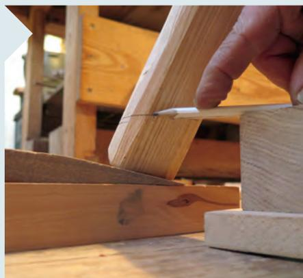
**8** Reißen Sie mit Holzklötzen vom Boden her die Länge der Beine parallel an, sodass die Oberkante der Bank dann auf 98 cm liegt. Nun schneiden Sie die Beine auf Länge. Durch Trocknen und Schwinden verliert die Bank 15 mm an Höhe, dies ist einkalkuliert.
