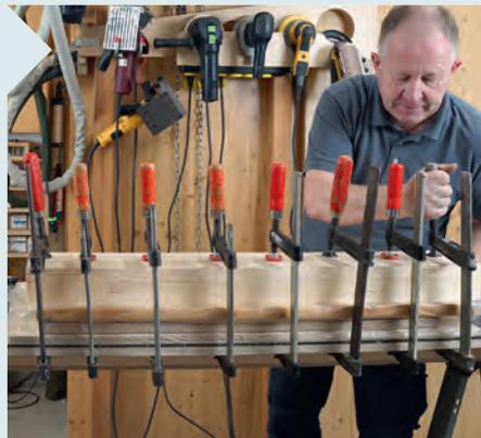
**8** | Die Zulagen verteilen den Druck der Schraubzwingen auf die Fläche. Nach dem Trocknen des PU-Klebers können Sie das Klebeband entfernen.
