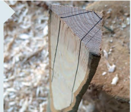
**3** Nachdem auf den Außenseiten der Beine eine Fläche angelegt ist, reißen Sie die Zinken an. Die Beine bleiben zunächst noch auf der vollen Rohlänge von 1,50 m. Erst nachdem die Verbindungen eingepasst sind, erfolgt das Ablängen.
