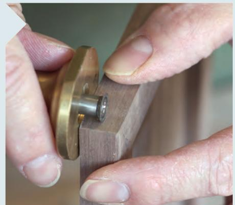
**11** Nachdem der Leim in der Tür abgebunden hat, bohren Sie die Löcher für Scharnier und Bolzen hinein. Zeichnen Sie die Bohrlöcher exakt im Türrahmen an: das Scharnier genau mittig, das Bolzenloch jedoch sehr nah an der Oberfläche des äußeren Türrahmens.
