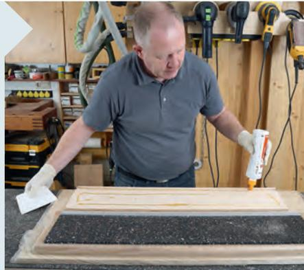
**5** | Platzieren Sie beim Zusammenkleben die erste Lage auf einer weiteren Platte, die später als Zulage zum Spannen dient. Eine untergelegte PE-Folie verhindert ungewolltes Anhaften. Dosieren Sie die Auftragsmenge so, dass möglichst kein Überschuss entsteht.
