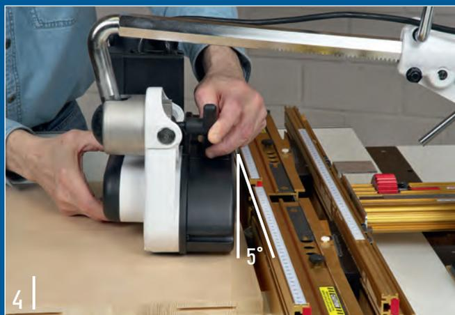
4 | Damit die Rollen das Werkstück immer dicht gegen den Fräsanschlag schieben, ist es wichtig, dass Sie den Vorschubapparat zum Schluss noch etwa 5° schräg zur linken Anschlagfläche hin schwenken.
