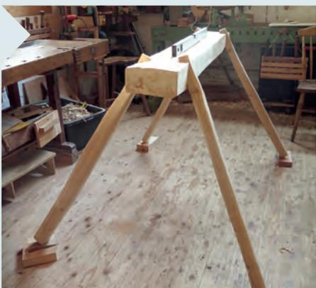
**7** Nivellieren Sie nun die Bank mit fest eingeschlagenen Beinen auf einem ebenen Untergrund mit Hilfe von Keilen, bis sie waagrecht steht.
