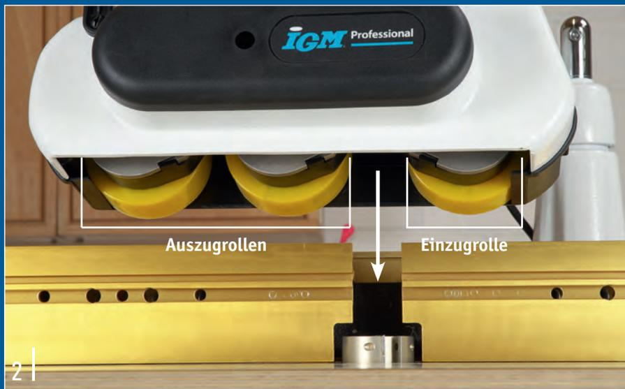
2 | Die Antriebseinheit besteht aus drei federgelagerten Rollen: Eine für den Einzug, zwei für den Auszug. Dazwischen befindet sich eine Lücke, die etwa zur Mitte des Fräsers ausgerichtet wird. Das gewährleistet einen optimalen Einzug und Weitertransport.
