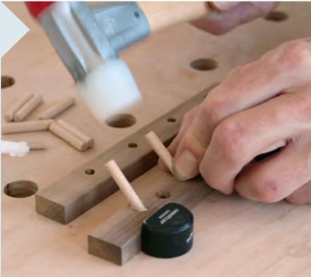
**6** Schlagen Sie die Rundhölzer inklusive eines Tropfens Leim mit einem Hammer in die schrägen Bohrlöcher ein. Die Rundhölzer dienen auch als Anschlagpunkt für die Tür.
