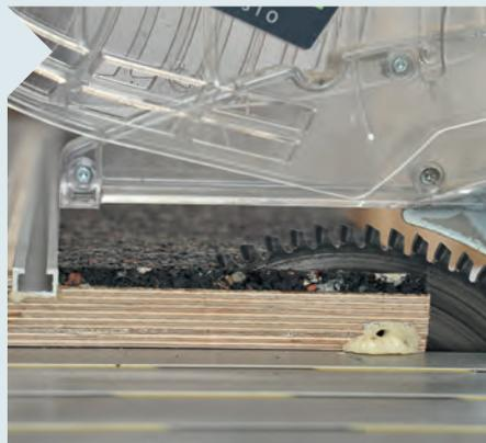
**11** | Zum Ablängen kommt ein Sägeblatt mit einer hohen Zähnezahl, idealerweise mit negativem Spanwinkel zum Sägen von Aluminium zum Einsatz. Anschließend können Sie die Oberflächen noch ölen, so gleiten die Werkstücke leichter daran entlang.
