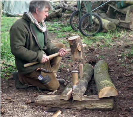
**1** Die 150 cm langen, möglichst astreinen Hartholzrollen für die Beine sowie die Arme für den Gummizug werden mit Holzhammer, Axt und Keilen in Viertelspaltlinge zerlegt: erst halbieren, dann vierteln. Axt und Holzhammer öffnen den Spalt.
