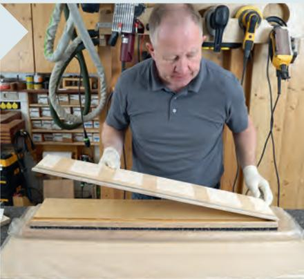
**7** | Da die zweite Außenseite etwas stabiler ist als die Variante mit der weichen Bautenschutz-Matte, kann sie von oben auf die Mittellage gelegt werden.
