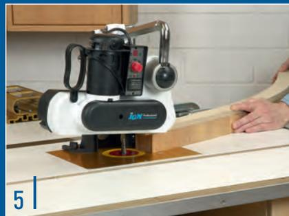
Ob ein Werkstück während der gesamten Fräsung immer dicht am Kugellager anliegt, hängt zum größten Teil von der korrekten Zuführung ab. Nutzen Sie dazu unbedingt einen Bogenfräsanschlag samt Zuführleiste.
