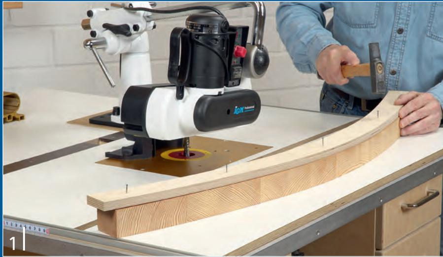
Das Werkstück sollte höchstens 3 mm über der Schablone vorstehen. An den Enden sollte die Schablone um mindestens 20 mm überstehen. Das sorgt für eine bessere Zuführung auf das Kugellager und erleichtert später das Abnehmen der Schablone.
