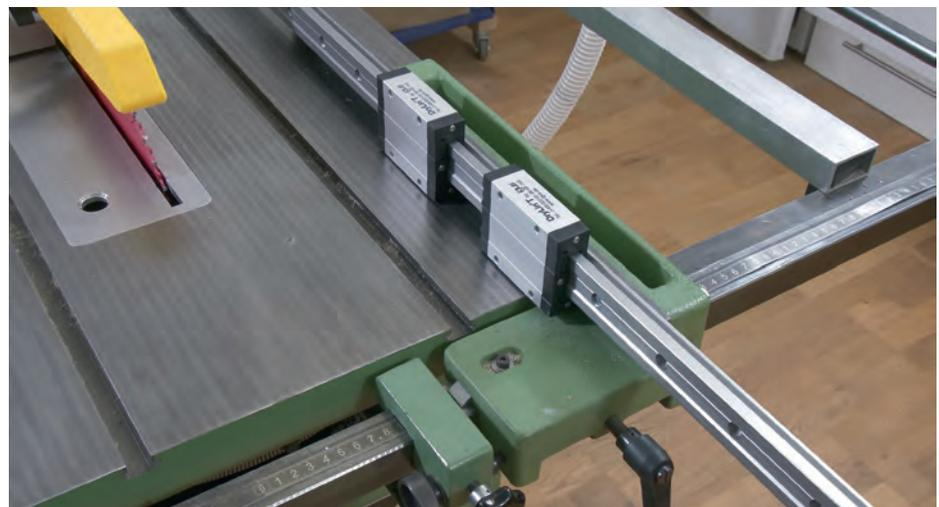
**4** | So sieht das Zwischenergebnis aus: Die Gleitschiene Länge von einem Meter erscheint üppig. Sie ermöglicht es aber, die Schlitzvorrichtung weit vom Sägeblatt wegzuziehen, um sicher umzuspannen. Hier wird auch deutlich, warum der Stahlstreifen Schiene und Gleiter etwas „anheben“ muss.
