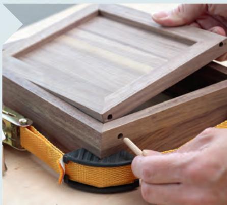
**15** Testen Sie den Korpus ohne Leim, um probeweise die Tür einzusetzen. In das obere Scharnierloch (Tür) stecken Sie einen Dübel. Hängen Sie die Tür ein. Fluchten die beiden Löcher an der Unterseite, führen Sie den Dübel von unten durch den Boden ein.
