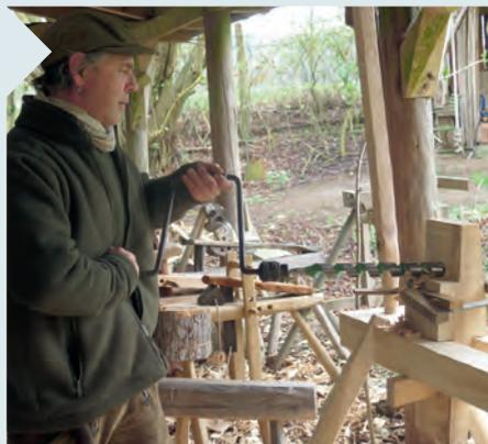
**14** | Direkt über der Abplattung des linken Reitstocks bohren Sie das Loch für den Kragarm ein. In der Seitenansicht liegt die Bohrung waagrecht, in der Draufsicht beträgt der Winkel 109 Grad zur linken Seite der Drehbank hin.
