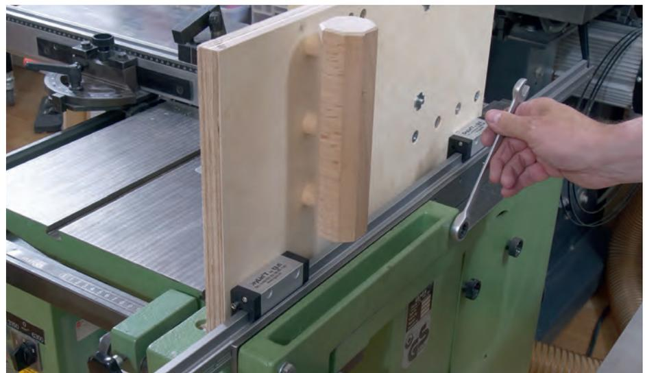
**8** Der kräftige Griff ist montiert und auch die Linearwagen sitzen nun fest am Grundbrett: Dann können Sie alles mit möglichst großen Schrauben (hier M8) durch den Grundkörper des Anschlags verbinden.
