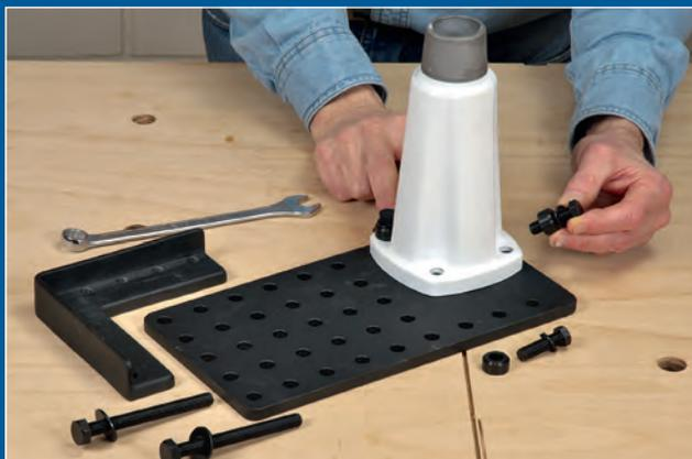
Für etwa 70 Euro bietet IGM auch eine passende Montageplatte an. Sie kann über den mitgelieferten Eckrahmen an der Platte schmaler Frästische (Voraussetzung: diese hat Überstand) gespannt werden. Dann sind keine Bohrungen im Maschinentisch nötig.
