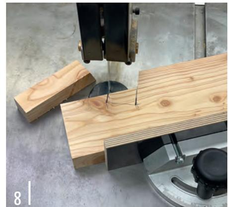
mit der Bandsäge eingearbeitet wird (Bild 4). Während Sie den kurzen Schnitt zur Erzeugung der Brust mit dem Queranschlag führen können, muss der lange Schnitt freihändig erfolgen.
