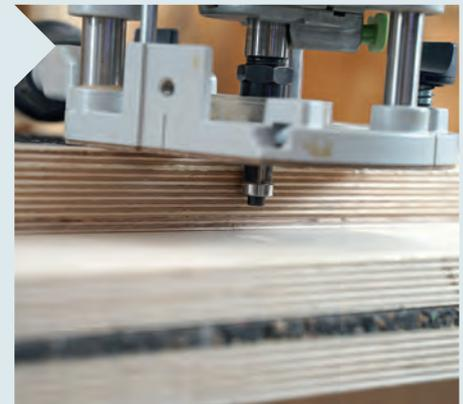
**9** | Mittels Bündigfräser wird der überschüssige Leim an den Längsseiten entfernt. So erhalten Sie eine saubere Fläche, um den Anschlag sauber für den Schnitt aufs Endmaß anzulegen.
