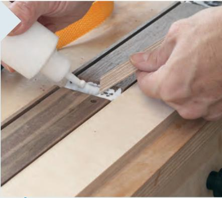
**18** Die vier Korpussteile werden mit Klebeband fixiert. Geben Sie in den Gehrungen Leim an, klappen Sie die Gehrungen zusammen. Bilden drei der Teile ein „U“, schieben Sie die Rückwand (Pos. 8) in die Nut. Schließen Sie den Korpus durch das vierte Teil.
