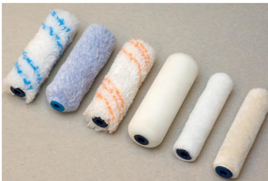
Bezüge (von links): 1. Polyamid-Blaufaden-Plüsch, 2. verdichteter Polyester, 3. verwebter Mikrofaser-Orangefaden, Polyester, 4. superfeiner Schaumstoff, Polyurethan, 5. Mikrofaser, Polyester, 6. Mohairwalze aus Angora-Ziegenhaar mit borstigen Fasern.
