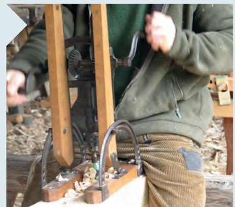
**9** Nun werden das Langloch für die beiden Spindelstöcke sowie die Bohrungen für die Arme, die den Gummizug tragen, angerissen und gebohrt. Das Langloch sitzt außermittig, damit die Antriebschnur sich nicht am Bett reibt. Die Arme sind 5° nach außen geneigt.
