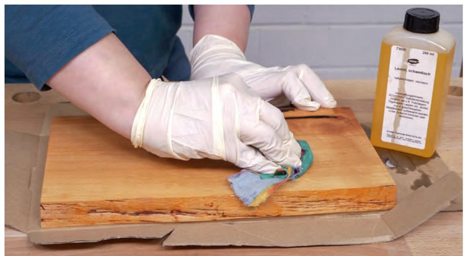
Dieses überschüssige Öl müssen Sie nun dringend mit einem sauberen Baumwoll-Lappen entfernen. So verhindern Sie, dass das Werkstück dauerhaft klebt. Achten Sie auch auf Laufnasen auf Kanten und Unterseiten der Werkstücke.
