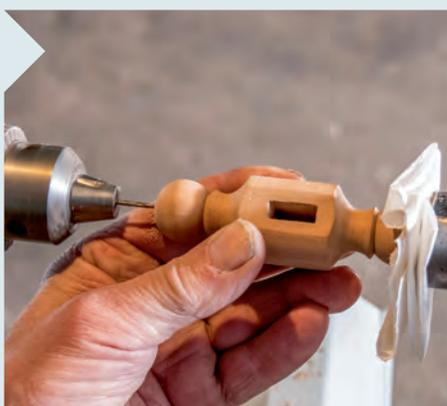
**14** | So bohren Sie: 1,5-mm-Bohrer für einen 2-mm-Nagel. Die Reitstockpinole wird „hohl“, also ohne Körnerspitze, eingesetzt und sachte nach vorne gedreht.
