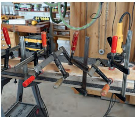
Beim Verleimen arbeiten Sie von zwei Seiten mit Schraubzwingen. Die waagrecht angebrachten Zwingen bringen den Druck auf die Leimfuge. Die senkrechten Zwingen drücken auf die Zulage und verhindern das Umklappen des Materials.
