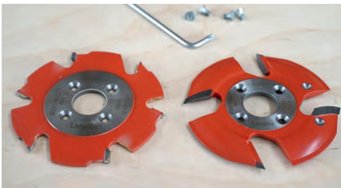
Im direkten Vergleich sind beide Werkzeuge gut zu unterscheiden. Links im Bild ist der flache Nutfräser, rechts der schiffchenförmige Astspot- oder Harzgallenfräser.
