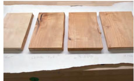
Im Vergleich (von rechts nach links): Halboil, Firnis, Leinöl (zum Vergleich ganz links eine noch ungeölte Platte). Leinöl riecht dezent, leicht nussig, Firnis etwas intensiver und Halboil sondert noch lange einen sehr intensiven Geruch ab.
