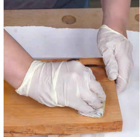
Falls nötig, entstauben Sie die Fläche noch einmal mit einem sauberen Tuch. Geben Sie dann eine sehr kleine Menge des Öls auf die Fläche und verteilen Sie es gleichmäßig. Die Fasern sind beim zweiten Durchgang schnell gesättigt.
