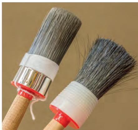
Der Ringpinsel in Malerqualität links verfügt über eine Metallzwinde, in der mit einem einfachen Fadenvorband hochwertige Naturborsten gefasst sind. Der rechte Pinsel ist von so minderlicher Qualität, dass seine Borsten schon vor der Benutzung aus dem Büschel fallen.
