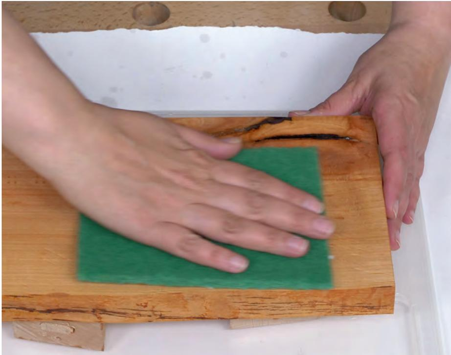
Lassen Sie dem Öl eine angemessene Zeit, um voll durchzutrocknen. Je nachdem, ob Sie Leinölfirnis oder Leinöl pur auftragen, kann es ein bis zwei Tage dauern, bis dieser Zustand erreicht ist. Schleifen Sie nun die Flächen mit einem Schleif-Vlies zwischen.
