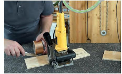
Bekleben Sie die Grundplatte und die Haltestreifen mit transparentem breitem Klebeband. Ein Streifen Klebeband über der Längsfuge verhindert, dass der Leim durchschlägt.
