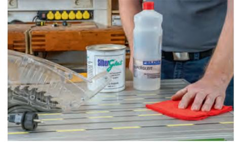
Wird hin und wieder etwas Gleitmittel auf Anschlägen und Maschinentisch aufgetragen, ist ein gleichmäßiger Vorschub garantiert.
