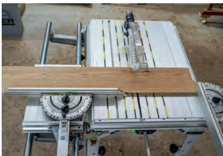
Wenn Sie den Parallelanschlag zum Ablängen nutzen, ziehen Sie ihn so weit zurück, dass er keinen Kontakt mehr zum Holz hat, wenn der Trennschnitt erfolgt ist.
