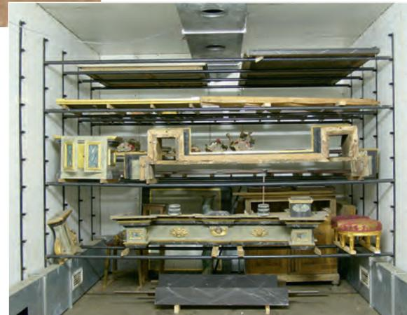
Bis zu drei Tage bleibt die Kammertür verschlossen, die 55° im Kern jedes Objekts erreicht und einige Zeit gehalten wird.
