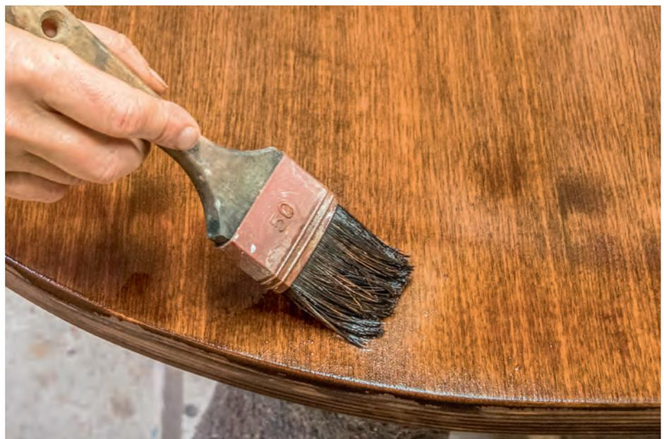
Pinsel mit Metallzwingen können dunkle Oxidations- oder Rostflecken hervorrufen. Daher sollten Beizpinsel mit einer voll gegossenen Kunststoffzwinge ausgestattet sein.
