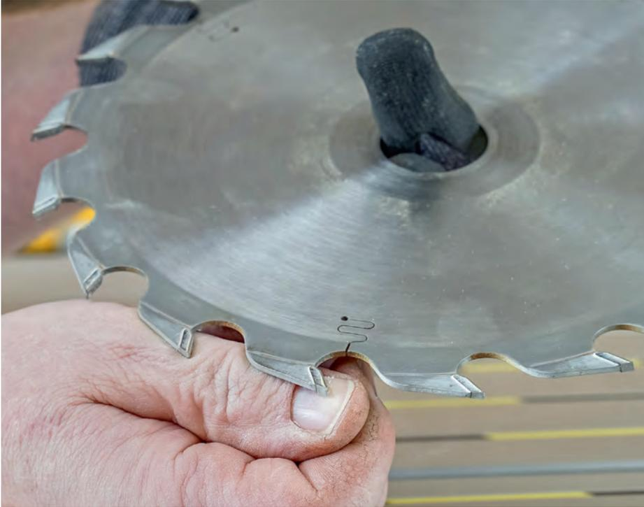
Über leichtes Kratzen am Fingernagel lässt sich die Schärfe eines Sägeblattes einfach kontrollieren. Entsteht kein Abrieb, muss das Sägeblatt nachgeschärft werden.
