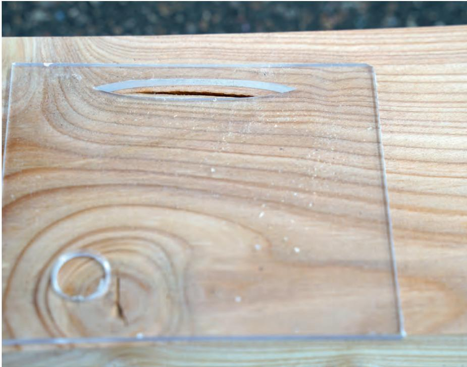
Nun offenbart sich auch der Sinn der Plexiglasschablone: Durch die Öffnung in der Plexiglasschablone ist es möglich, die genaue Position der Fräsung zu bestimmen. Die Bohrung ist zum Aufhängen der Schablone gedacht.
