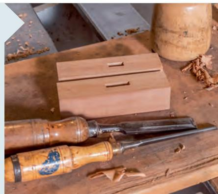
**3** Stemmen Sie die beiden vorgebohrten Schlitz eckig aus. Die Zirkelleiste wird später so ausgehobelt, dass sie in den festen Zirkelkopf eingeleimt werden kann. Der Schlitz des beweglichen Kopfs wird dann bei Bedarf noch etwas weiter gefeilt.
