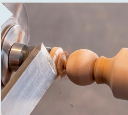
**12** | Stechen Sie mit einem Meißel zum Abschluss soweit herunter, dass der Rest nahezu von selbst abfällt. Versäubern Sie den Ansatz mit einem Schnitzmesser und etwas Schleifpapier.
