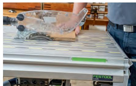
Für das Sägen quer zur Faser ist ein Sägeblatt mit einer mittleren Zähnezahl (48 Zähne) gefragt. Stellen Sie die Sägeblatthöhe so ein, dass der Ein- und Austrittswinkel des Sägeblattes in etwa gleich ist.
