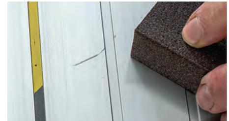
Kratzer und Schadstellen auf dem Maschinentisch hinterlassen sichtbare Spuren auf der Werkstückoberfläche. Ein Schleifschwamm schafft wieder eine glatte Oberfläche.
