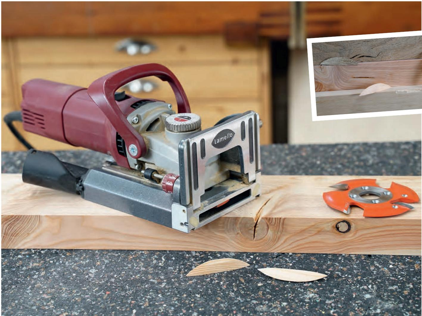
Setzen Sie den Fräser ein, ziehen Sie ihn wie den Flachdübelfräser fest und bauen Sie die Fräse wieder zusammen. Machen Sie mit laufender Maschine eine Probe fräsung in ein Opferholz.
