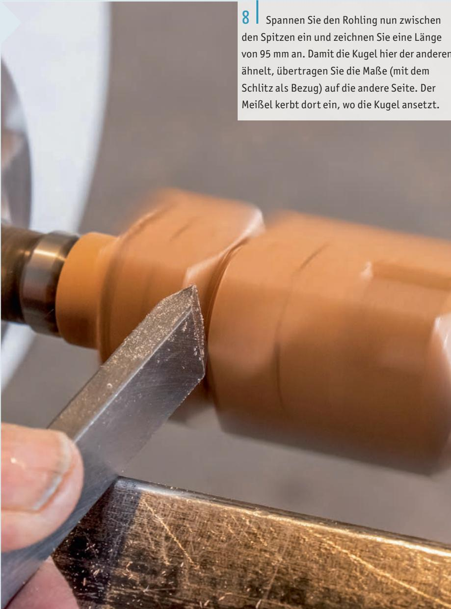
**8** | Spannen Sie den Rohling nun zwischen den Spitzen ein und zeichnen Sie eine Länge von 95 mm an. Damit die Kugel hier der anderen ähnelt, übertragen Sie die Maße (mit dem Schlitz als Bezug) auf die andere Seite. Der Meißel kerbt dort ein, wo die Kugel ansetzt.
