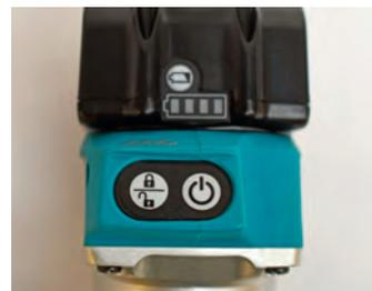
Großes Plus bei der Sicherheit: Der Schalter ist verriegelt. Erst mit dem Drücken beider Knöpfe kurz nacheinander startet die Maschine.
