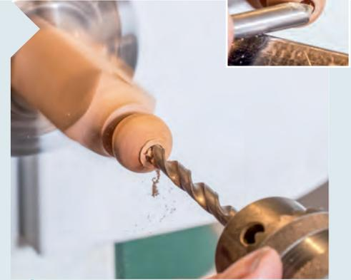
**7** | Bohren Sie jetzt mit 7,5 mm Durchmesser (für einen normalen sechseckigen Bleistift) 30 mm tief in das Ende des beweglichen Zirkelkopfs. Die kleine Röhre versäubert dann den Lochrand am Ende der kleinen Kugel.
