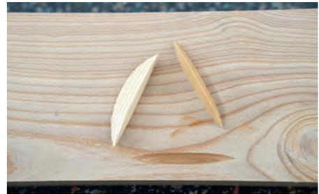
Die Fehlstelle ist sauber schiffchenförmig ausgefräst. Nun können Sie den Flicker auswählen, dessen Struktur am besten zur Stelle passt.
