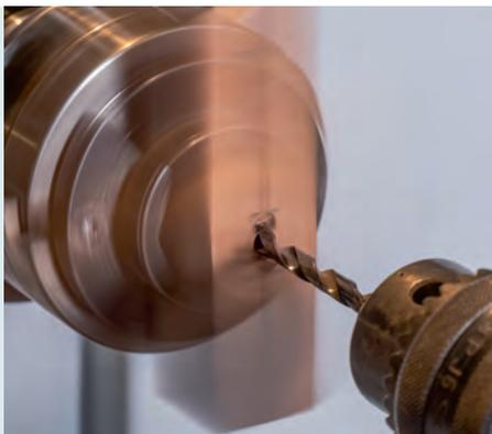
**1** Es geht los mit dem festen Zirkelkopf: Bohren Sie zunächst mit einem 6-mm-Bohrer so, dass ein 16 mm langer Schlitz entsteht. Der Schlitz beginnt 52 mm von einem Ende entfernt. Außermittig deshalb, damit noch Holz zum Einspannen des Zirkelkopfs bleibt.
