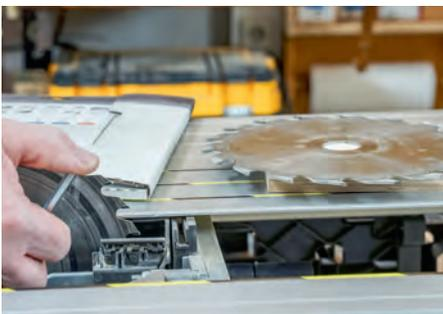
„So wie ich lauf, so geh ich auf“, so lautet eine Eselsbrücke zum Wechseln des Sägeblattes. Lagern Sie Ihre Sägeblätter am besten in der Originalverpackung. Passen Sie während des Sägeblattwechsels auf, dass die Schneiden nicht mit anderen Metallteilen in Kontakt kommen.
