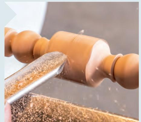
**10** | Im nächsten Schritt werden noch die Kanten im mittleren Bereich verrundet, bis fast der Schlitz erreicht ist.
