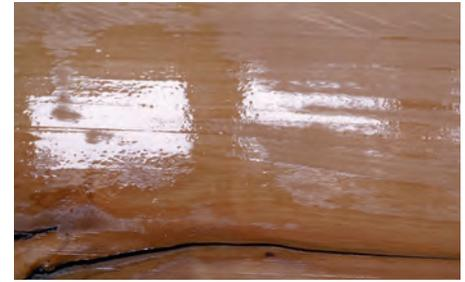
Satt heißt, dass Sie im Verlauf der ersten halben Stunde immer wieder Öl auftragen, bis die Fasern kein Öl mehr aufnehmen. Das erkennen Sie daran, dass das Öl nicht mehr aufgesogen wird, sondern an der Oberfläche stehen bleibt.
