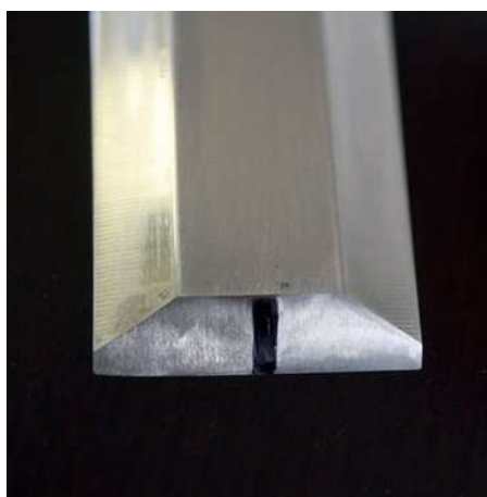
... im Ergebnis produziert der günstige 1000-er Stein (linke Seite) aber deutlich gröbere Riefen als sein nach JIS klassifiziertes Pendant (rechte Seite).
