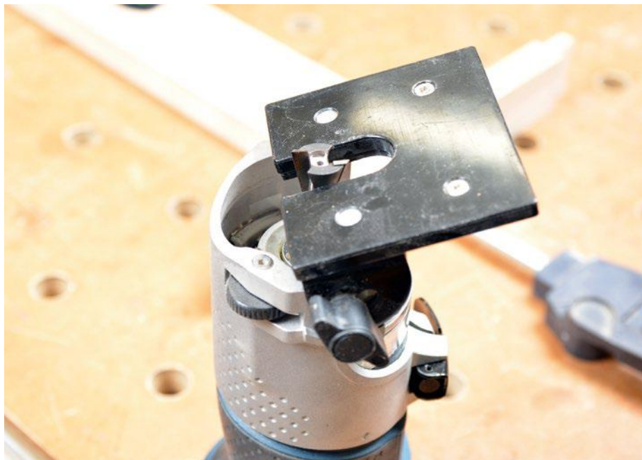
Eine Kantenfräse mit kippbarem Tisch ist die Voraussetzung für die hier gezeigte Technik der gefrästen Zahnleisten.
