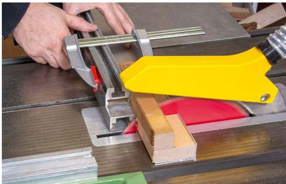
Am sichersten verläuft der Schnitt auf der Tischkreissäge mit ins Alu-Profil eingeklebten Holzleisten. Hier kann eine Hebelzwinde ansetzen und alles sicher spannen.
