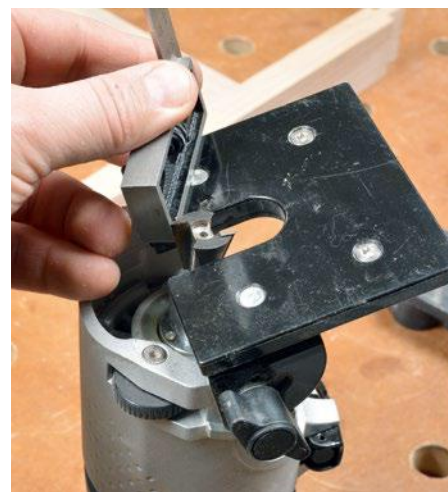
Die Schneiden des 15°-Gratfräasers werden mit einem geeigneten Hilfsmittel exakt 90° zur Grundplatte eingestellt. Damit ergibt sich genau das Fräsbild, welches für Zahnleisten ideal ist – ein 15°-Winkel der den unteren Grund ausarbeitet.
