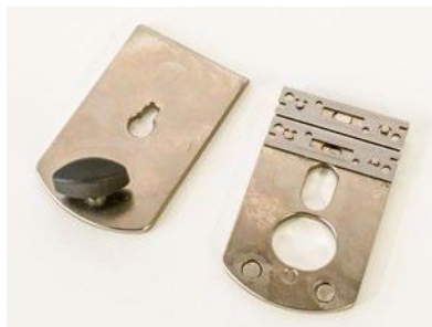
Zwei Wendemesser mit insgesamt vier Schneiden sind im Hobel untergebracht und können bei Bedarf schnell getauscht werden.
