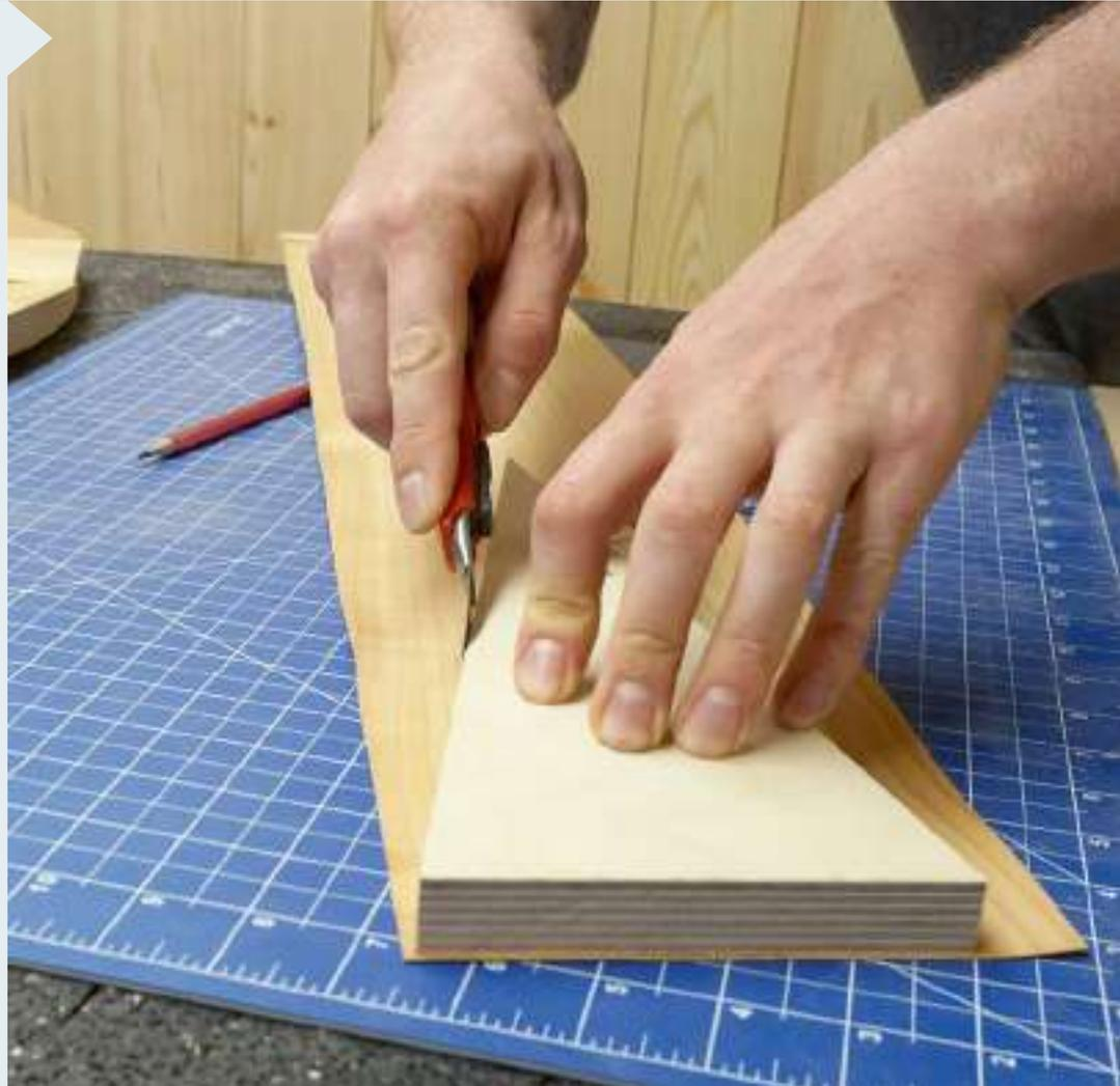
**11** | Schneiden Sie nun das Furnier der Tischplatten-Tortenstücke. Die kurze Basis der 22,5°-Schablone liegt rechtwinklig zu den Fasern. Fertigen Sie die Schablone 1 cm länger, so dass etwas Furnierüberstand entsteht.
