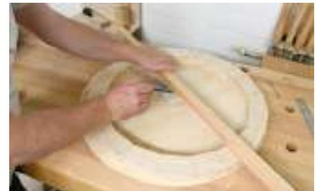
Leimen Sie zwei Reststücke aufeinander und fixieren Sie sie grob in der Mitte des Zwanzigecks. Markieren Sie auf je zwei gegenüberliegenden Segmenten deren Mitte und zeichnen ihre Verbindungslinie auf dem Mittenstück an. Der Schnittpunkt dieser Verbindungslinien ist die Mitte des Zwanzigecks.
