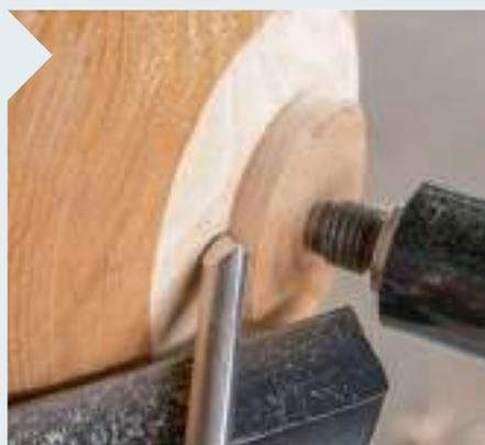
**9** | Mit dieser alternativen Schabetechnik sinkt die Oberflächengüte etwas, sie ist aber leichter zu handhaben: Drehen Sie die Röhre mit der Flute zum Werkstück. Dann liegt die hier untere Schneidenflanke am Holz an, die obere aber gerade eben nicht.
