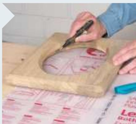
**7** Legen Sie den Rahmen auf eine 2 bis maximal 3 mm dicke Acrylglasplatte. Übertragen Sie jetzt mit einem Filzstift, der am Falzrand entlangläuft, die Ellipsenform.
