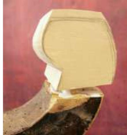
Leimen Sie das Teil (mit Hilfe von Dübelfindern) mit zwei diagonal platzierten Dübeln an das alte Bein. Beide Leimflächen sollten sich plan berühren. Durch Hobeln und Schleifen passen Sie Form und Oberflächengüte ans Bein an.
