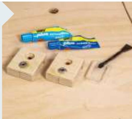
**7** | Die Bohrbuchsen kleben Sie mit Zweikomponenten-Epoxidharzklebstoff in den Bohrungen fest. Der Kleber soll dabei ruhig etwas neben der Buchse herausquellen und dort aushärten.
