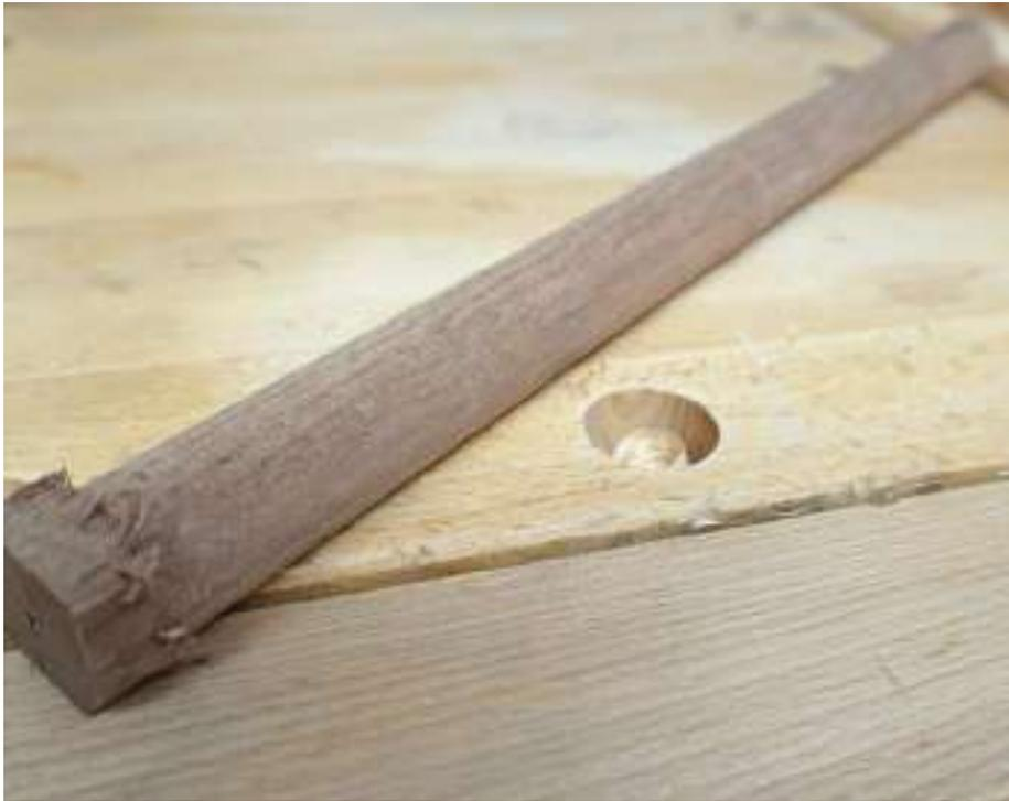
Um eine Kollision mit dem Mitnehmer zu vermeiden, ist der Fahrweg für die Kopierhülse kürzer als das Werkstück. Daher bleibt an den Enden immer noch ein wenig Material stehen. Kalkulieren Sie das vorab ein und trennen sägen Sie den Teil ab.
