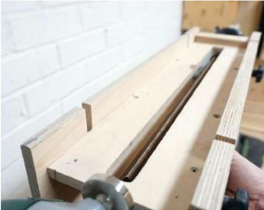
Wie auch beim Dreheln sollte vor dem Maschinenstart kontrolliert werden, ob sich das Werkstück frei drehen kann. Der Fräser der Oberfräse sollte immer auf den höchsten Punkt der angestrebten Kontur abgesetzt werden.
