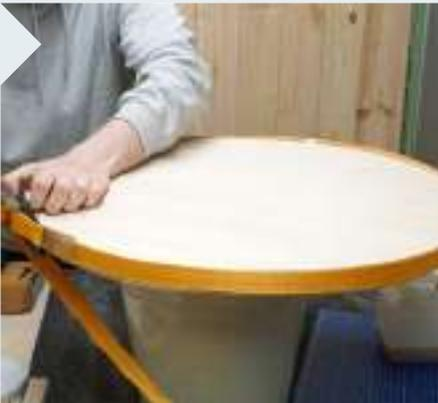
**10** | Ein Spanngurt und ein Stück Gummi als Zulage ermöglichen einen hohen Anpressdruck. Während des Spannens unbedingt kontrollieren, dass der Gurt überall gleichmäßig anliegt und den Druck mit Gefühl aufbauen.
