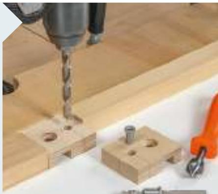
**6** | Jeder der beiden Bohrköpfe aus Multiplex bekommt neben der Nut noch eine 16 mm lange gehärtete Bohrbuchse (Innendurchmesser 4,5 mm). Dazu ein 8-mm-Loch bohren und den Lochrand großzügig ansenken.
