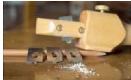
Handprofilhobel verfügen über verschiedene kleine Eisens, die in Höhe und Schräge einstellbar sind. Es ist dennoch ratsam, die Grundform der Profilleiste an der Kreissäge vorzubereiten.
