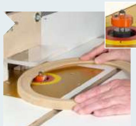
**9** Im letzten Schritt fräsen Sie mit einem Falzfräser samt Kugellager in die Rahmeninnenkante noch ringsum einen Falz zur Aufnahme von Acrylglas, Bild und Rückwand ein.
