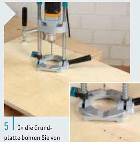
**5** In die Grundplatte bohren Sie von der Mitte ausgehend zunächst zwei 5-mm-Löcher im Abstand von 45 mm. Das ist bei 50 mm langen Gleitern der kleinstmögliche Abstand, sonst stoßen die Gleiter zusammen. Bei Bedarf setzen Sie noch mehr Löcher (siehe Zeichnung).
