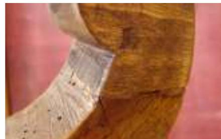
Im Farbton des alten Stückes gebeizt, ist der angesetzte Fuß schon recht unauffällig, auch wenn hier die Faserrichtung bewusst nicht parallel verläuft. Nun kann das ganze Möbelstück fertig oberflächenbehandelt werden.
