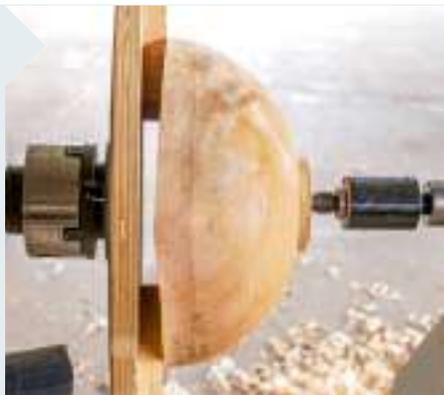
**5** | Darauf wird der Rohling so gedreht, bis die beiden gegenüberliegenden „Tiefpunkte“ seines Randes auf den Tortenstücken liegen. Es kann etwas dauern, bis die richtige Position gefunden ist. Schließlich drückt ihn die mitlaufende Körnerspitze wieder an.
