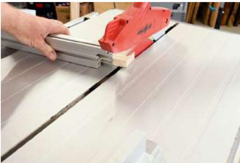
Schneiden Sie 40 identische Segmente in Trapezform. Der Winkel beträgt auf jeder Seite 9°. Die Tischkreissäge ist dafür mit ihrem verstellbaren Queranschlag ein geeigneter Helfer. Sägen Sie die Außenkante der Ausgangs-Leiste im 9°-Winkel ab.
