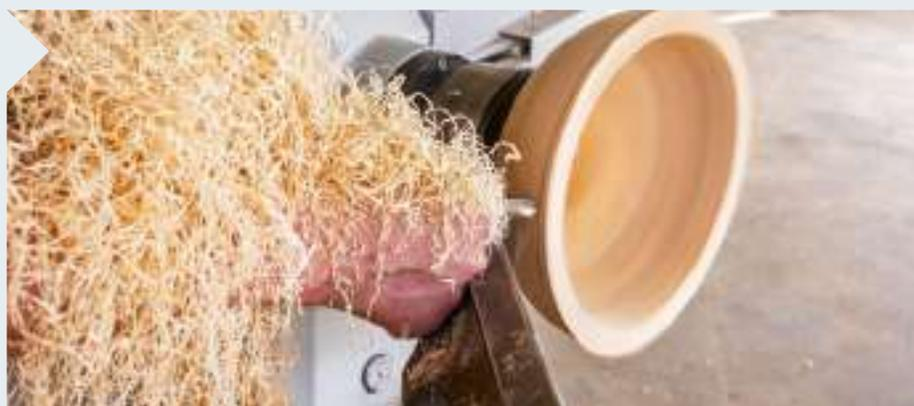
**12** | Dazu dient die Schalenröhre in sehr offener Haltung (Flute weist nach oben) mit sehr geringer Spanabnahme. Auch die schabende Technik (siehe Bild 9) kann hier eingesetzt werden. Schleifen Sie dann bereits die Außenseite.
