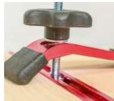
Ganz genaues Arbeiten ist unumgänglich: Hat die Schiene Spiel in der Nut (hier ein guter halber Millimeter), hebt sie sich ohne Verschraubung (wie hier gezeigt) deutlich.
