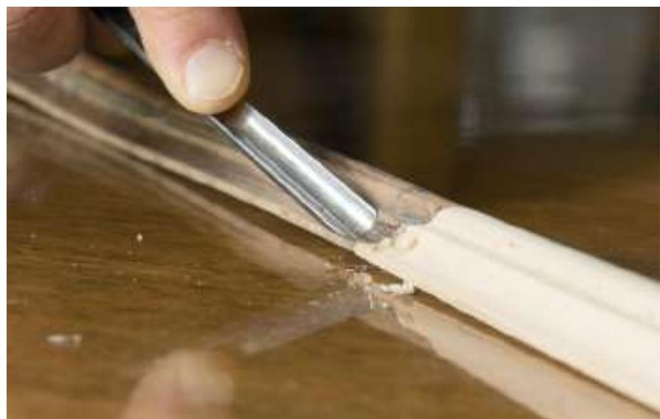
Der gleiche Arbeitsschritt kann auch mit einem gerundeten Schnitzisen mit dem passenden „Stich“ ausgeführt werden. Achten Sie darauf, so flach zu schneiden, dass das Profil keine Dellen bekommt.
