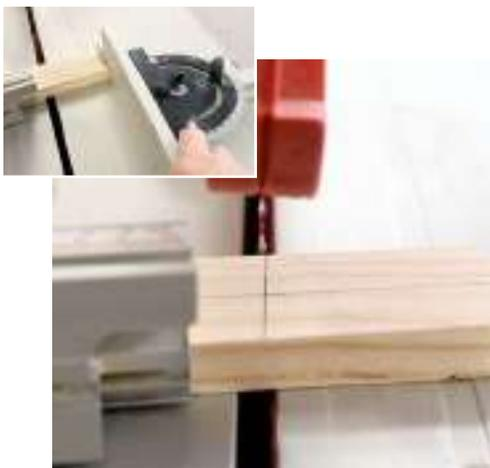
Sägen Sie links neben dem Riss. Stellen Sie den Parallelanschlag als Abstandshalter für immer wieder identische Stücke ein. Positionieren Sie ihn unbedingt vor dem Sägeblatt und bewegen Sie dann den Queranschlag nach vorn. Beim Schnitt dürfen nie beide Anschläge in Kontakt zum Holz sein.
