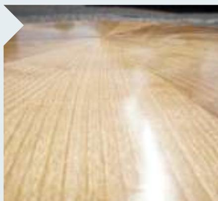
**28** | Carnaubawachs, halb und halb gemischt mit Schellackwachs, und dazu ein Polierpad: Auch Ungeübte erlangen so in kurzer Zeit einen angenehmen Glanzgrad, der sich bei Bedarf schnell und einfach reparieren lässt.
