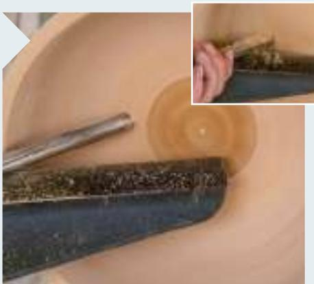
**14** | Drechseln Sie auch den Innenbereich in Stufen, so dass immer möglichst viel Masse im Inneren bleibt. Das wirkt aktiv gegen das Flattern des Werkstücks. Vollenden Sie die Innenseite mit dem Rundschaber und Schleifpapier.
