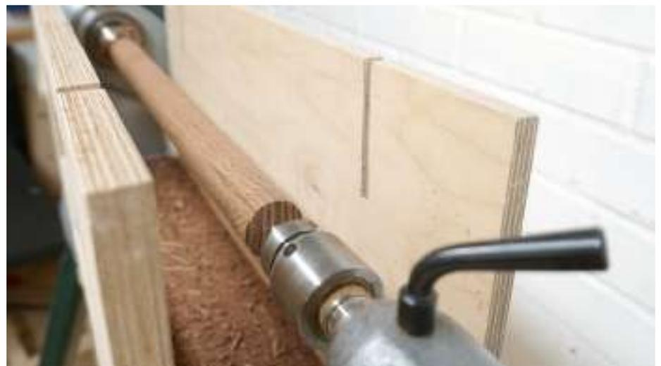
Geschafft: Das eckige Stück geräucherte Robinie ist nun in unter zwei Minuten zu einem Rundstab geworden. Der feine Staub wird abgesaugt, gröbere Späne verteilen sich leider wie beim Dreheln üblich ein wenig in der Werkstatt.
