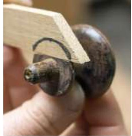
Die Eichenleiste ist genau auf die Dicke des fehlenden Teilchens ausgehobelt. Das aufgezeichnete Kreissegment sägen Sie möglichst genau mit der Dekupiersäge aus.
