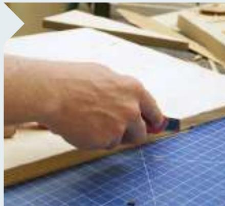
**13** | Nachdem vier Abschnitte mit Klebeband zu einem Viertelkreis verbunden sind, werden diese an einem rechtwinkligen Brett mit einem Cutter besäumt. Die addierten Abweichungen lassen sich auch hier bereits als kleiner Überstand erkennen.
