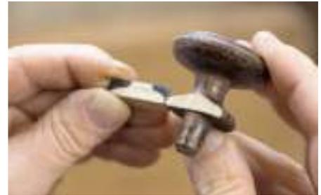
Übertragen Sie das Profil des Knopfes auf das ausgesägte Kreissegment und nehmen schon mit Raspeln und Feilen einen Teil des überflüssigen Materials ab.
