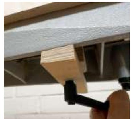
Die Steckklötze an der Unterseite der Vorrichtung passen exakt in das Bankbett. Unten werden sie je durch ein Klemmbrett stramm mit der Drechselbank verbunden.
