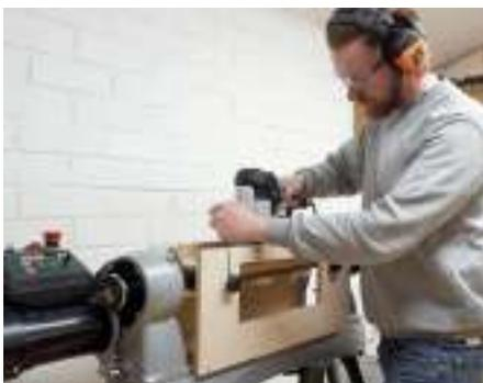
Und jetzt kann es losgehen: Drehselbank anschalten, Fräse einschalten und mit Gefühl die erste Bahn fräsen.
