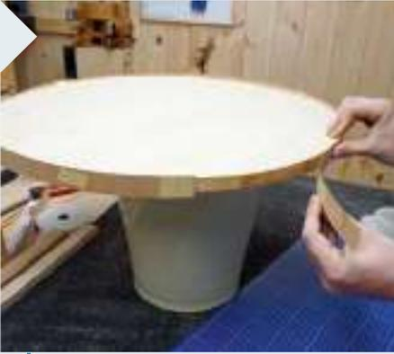
**9** | Nun zur Tischplatte: Wenn der Fischleim aufgetragen ist, kann dieser für ein paar Minuten trocknen. Dann erst drücken Sie rundum das Furnier an. Die Anfangshaftung ist höher, das Verrutschen wird unwahrscheinlicher.
