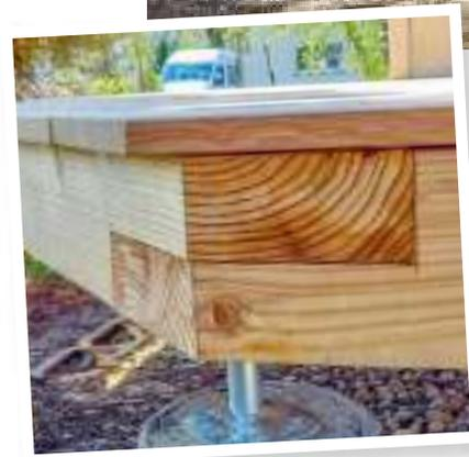
**Ein zerlegbarer Tisch** mit zwei Bänken zum Einsatz auf Mittelaltermärkten stand auf dem Plan. Die Bretter habe ich am Kern mit der Bandsäge aufgetrennt. Anschließend wurde mit der Kreissäge der Naturrand entfernt und die Bretter allseitig gehobelt. Die Nuten für die Lamellos sind eingefräst und konnten mit selbst konstruierten Verleimzwingen zu einer Tischplatte verleimt werden. Die Unterseite
