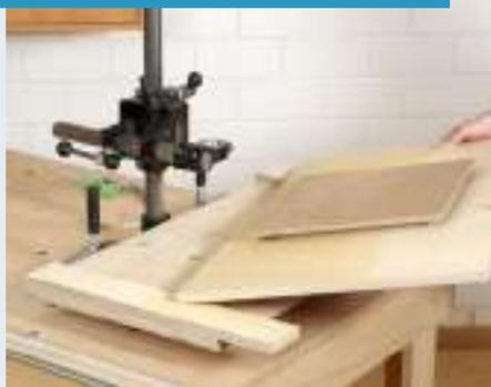
**1** Die Grundplatte samt Drehteller befestigen Sie als nächstes mit zwei Hebelzwingen auf dem Bohrständler. Zwei Distanzleisten bieten Platz für die Kontermuttern.
