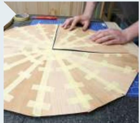
**14** | Doppelte Fleißarbeit: Das Gegenzugfurnier für die Unterseite der Platte ist ein Muss und wird ebenfalls in diesem Muster gelegt. Durch das rechtwinklige Besäumen passen alle Viertelstücke auf jeden Fall zusammen.
