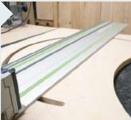
**3** Die Zargen-Biegeschablone fräsen Sie mit einem um 26 mm (Zargendicke plus Überstand) mm kleineren Radius als die Tischplatte. (Fräserdurchmesser: 16 mm) Der folgende Schnitt mit der Handkreissäge läuft durch den Zirkelmittelpunkt.
