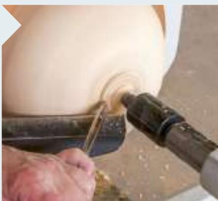
**16** | Arbeiten Sie mit der Schalenröhre behutsam und abwechselnd von außen nach innen und von innen nach außen. Ziel ist eine Art Standing, der verhindert, dass die fertige Schale kipzelt.
