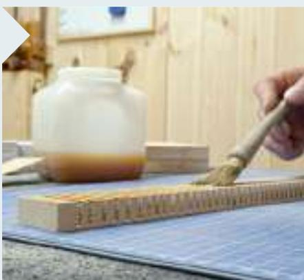
**6** Für die Zargenteile schlitzten Sie massive Kirsche mit der Kreissäge im Abstand von etwa 6 mm. Lassen Sie 2 mm Restmaterial in der Dicke stehen. Tragen Sie anschließend auf beiden Seiten Leim auf.
