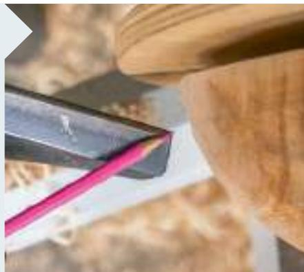
**6** | Stellen Sie die Handauflage neben den Schalenrand und drehen Sie die eingespannte Schale von Hand. Mit leichten Handschlägen sorgen Sie dafür, dass die beiden „Spitzen“ des ovalen Rohlings je mit gleichem Abstand am Stahl vorbeifliegen.
