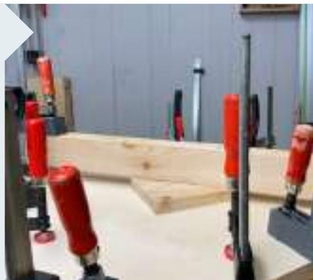
**16** | Pressen Sie die beiden Furnierscheiben auf die runde Platte, indem Sie zwei Hilfsplatten fest aufspannen. Ein mittig aufgelegter Klotz mit einer darüber gelegten Latte sorgt für Extra-Druck in der Mitte.
