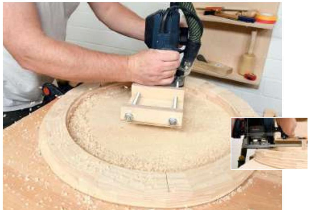
Der Mittelpunkt dient als Drehpunkt für einen Fräszirkel. Fräsen Sie zuerst den Innenradius (hier 230 mm) und dann den Außenradius (270 mm) mit einem Nutfräser, mindestens 15 mm tief. Nehmen Sie dann den Ring von der Platte (ein Cuttermesser hilft beim vorsichtigen Lösen des Klebebands).
