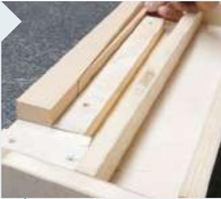
**21** | Ab dem dritten Schnitt werden die vorherigen Abschnitte benötigt: Sie erhöhen die Auflagefläche und das Bein kann festgekeilt werden, ohne beim Sägen zu verrutschen.
