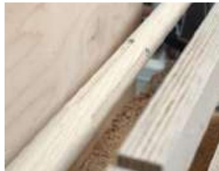
Kannelierungen können so einfach sein: Die Spindel der Drechselbank wird in den gewünschten Rastpunkten arretiert. Ganz ohne Werkstückdrehung können Sie dann solche Ziernuten oder auch Zapfenlöcher fräsen.
