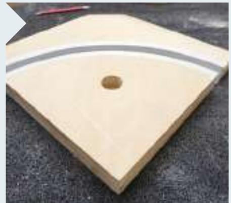
**5** Halbieren Sie die Abschnitte noch einmal und schrauben Sie dann die beiden Viertelkreise und die beiden Außensegmente je aufeinander. Klebeband schützt die Pressflächen vor Leim und das Loch ermöglicht das Einstecken der Zwinge.
