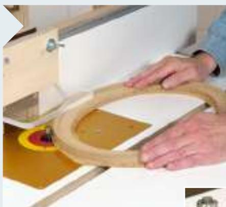
**7** Wechseln Sie auf den Frästäsch; den Rest fräsen Sie hier mit einem Bündigfräser sauber bis zur Ellipsenform ab. Ein Spiralnutfräser liefert hier die besten Ergebnisse.
