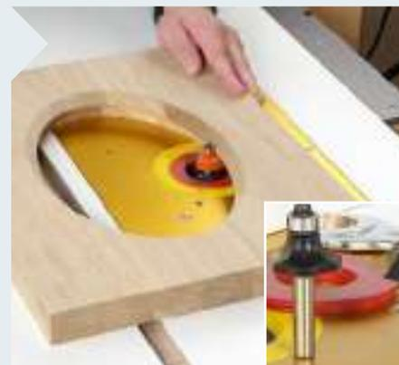
**5** Die Außenkante des Ausschnitts können Sie sehr gut mit einem Fassefräser samt Kugellager bearbeiten (kleines Bild). Danach fräsen Sie wieder von der Gegenseite aus schrittweise den Falz für die Acrylglasplatte und Rückwand ein.
