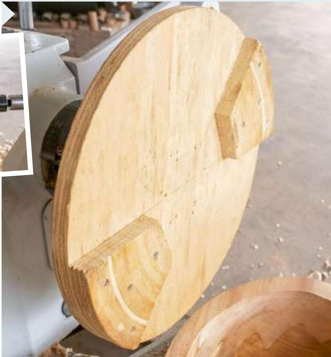
**4** | Variante 2: Eine runde, dicke Multiplex-Scheibe (hinten mit Planscheibenring im Futter befestigt) mit zwei aufgeschraubten „Tortenstücken“ aus dem gleichen Material, die etwa je 20° des Umfangs einnehmen. Sie liegen einander genau gegenüber.
