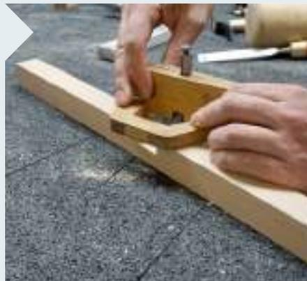
**25** | Ein Grundhobel ist das perfekte Werkzeug zum Anpassen von Überblattungen. Ein selbst gebautes Exemplar funktioniert hier genauso gut wie etwas Gekauftes.
