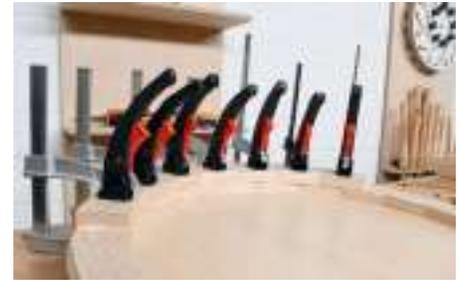
Leimen Sie das zweite Zwanzigeck um eine halbe Segmentlänge versetzt aufs erste. Der Leimauftrag erfolgt auf den Stirnseiten und auf der Fläche. Gehen Sie hier Schritt für Schritt vor und achten Sie auf geschlossene Spalte.
