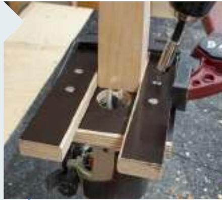
**22** | Fräsen Sie die Nut für die Aufnahme der Zarge mittig ein. Wer keinen Frästisch hat, kann sich mit ein paar Abschnitten behelfen: Das Kantholz wird zwischen den Abschnitten eingespannt und mittig ausgerichtet, die beiden Schienen festgeschraubt.
