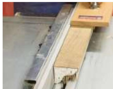
Nun zu einer Profil-Rekonstruktion: Fertigen Sie eine Papierschablone für das Hirnholz. Sägen Sie im Abstand von einigen Millimetern bis an das Profil heran. Lassen Sie zur Sicherheit außen Streifen stehen, damit die Leiste nicht in die Kreissäge kippen kann.
