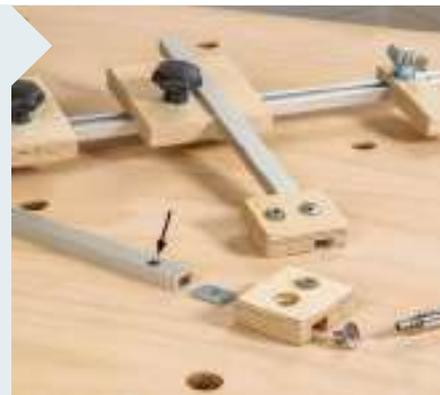
**8** | Den Bohrkopf befestigen Sie mit einer Gleitmutter (oder einer einfachen Sechskantmutter) und einer M8 x 15 mm Senkkopfschraube. Dazu müssen Sie in die T-Nut-Schiene noch eine 8,5 mm Bohrung einbringen (Pfeil).
