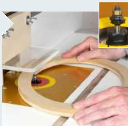
**8** Die Außen- und Innenkanten des Rahmens können Sie danach ganz nach Geschmack mit einem Kugellagerfräser (hier ein 4-mm-Abrundfräser) profilieren.
