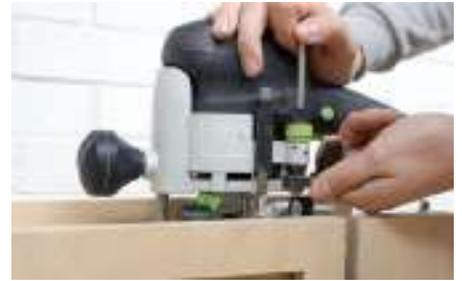
An der Oberfräse stellen Sie über den Tiefenanschlag die Start-Frästiefe ein. Nutzen Sie später den fein eingestellten Revolveranschlag, um die nächste Schicht (maximal 3 mm tiefer) abzutragen.
