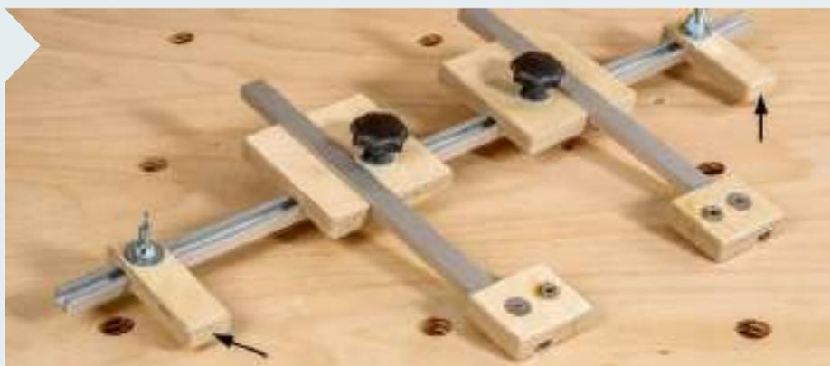
**9** | Ratsam ist es, die Vorrichtung noch mit zwei seitlichen Anschlägen (Pfeile) auszustatten. Das hält die Vorrichtung sicher in Position und sie kann nicht mehr verrutschen. Alle nach außen zeigenden Kanten werden zum Schluss noch abgerundet ( $R = 3 \text{ mm}$ ).
