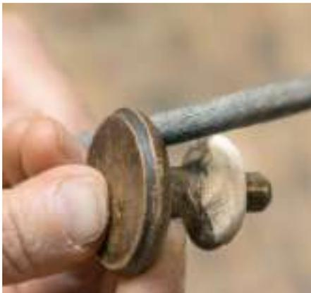
Die exakte Rundung sollte erst am vollständig zusammengesetzten Knopf fein ausgearbeitet werden. Eine im Durchmesser passende Rundfeile und Schleifpapierröllchen helfen, die endgültige Form zu finden.
