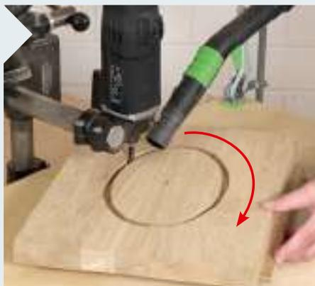
**3** Danach schalten Sie den Fräsmotor ein, senken den laufenden Nutfräser etwa 5 mm tief ins Holz und drehen das Werkstück einmal komplett im Uhrzeigersinn, bis die Ellipsenform gefräst wurde. Das Ganze mit dann weiteren 6 mm Frästiefe wiederholen.
