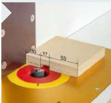
**2** Im Handel gibt es passend zur Schienenbreite auch einen 17-mm-Nutfräser. Die Nut können Sie aber auch mit einem kleineren Nutfräser in zwei Frässhritten herstellen.
