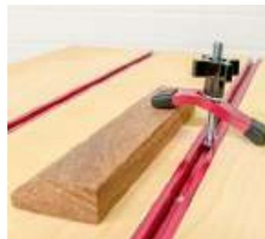
Das fertig zu kaufende Zubehör wie die Niederhalter überzeugen und nutzen die Spannkraft der Schienen in ihren Gratnuten optimal aus.
