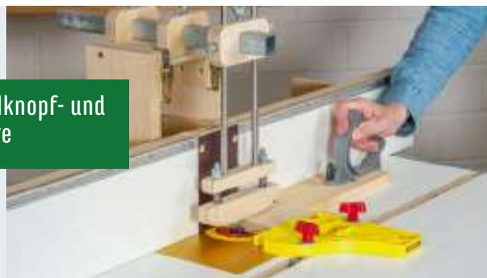
**1** Zuerst fräsen Sie in die 100 x 100 mm Multiplexbrettchen (18 mm dick) die 17 mm breiten Nuten. Wichtig: Solche Kleinteile nur mit Andruckvorrichtung und Winkelbrett über den Fräser schieben!
