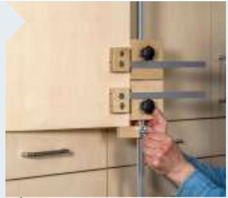
**5** | Verschiebekreuze und Bohrköpfe lassen sich völlig variabel auf der T-Nut-Schiene anordnen. Dadurch sind auch alle Arten von senkrechten Griffpositionen für Schranktüren blitzschnell und wiederholgenau einstellbar.
