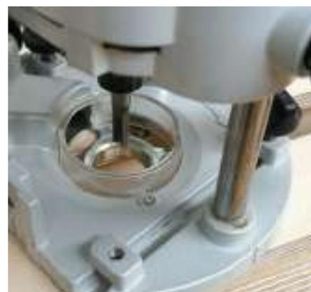
Die Kopierhülse der Oberfräse sollte möglichst spielfrei in der Nut der Aufnahme zu bewegen sein. Sehr wichtig: Wählen Sie die Endpunkte der Nut unbedingt so, dass der Fräser in keinem Fall in Kontakt mit Bauteilen der Drechselbank kommt.
