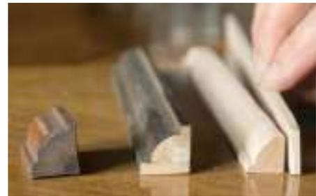
Dieses kleine Stab-Profil rechts im Bild ließ sich zum Teil mit der Oberfräse herstellen. Die gerade Leiste ist mit der Kreissäge entstanden. Zusammengesetzt ergeben sie das gewünschte fehlende Profil.
