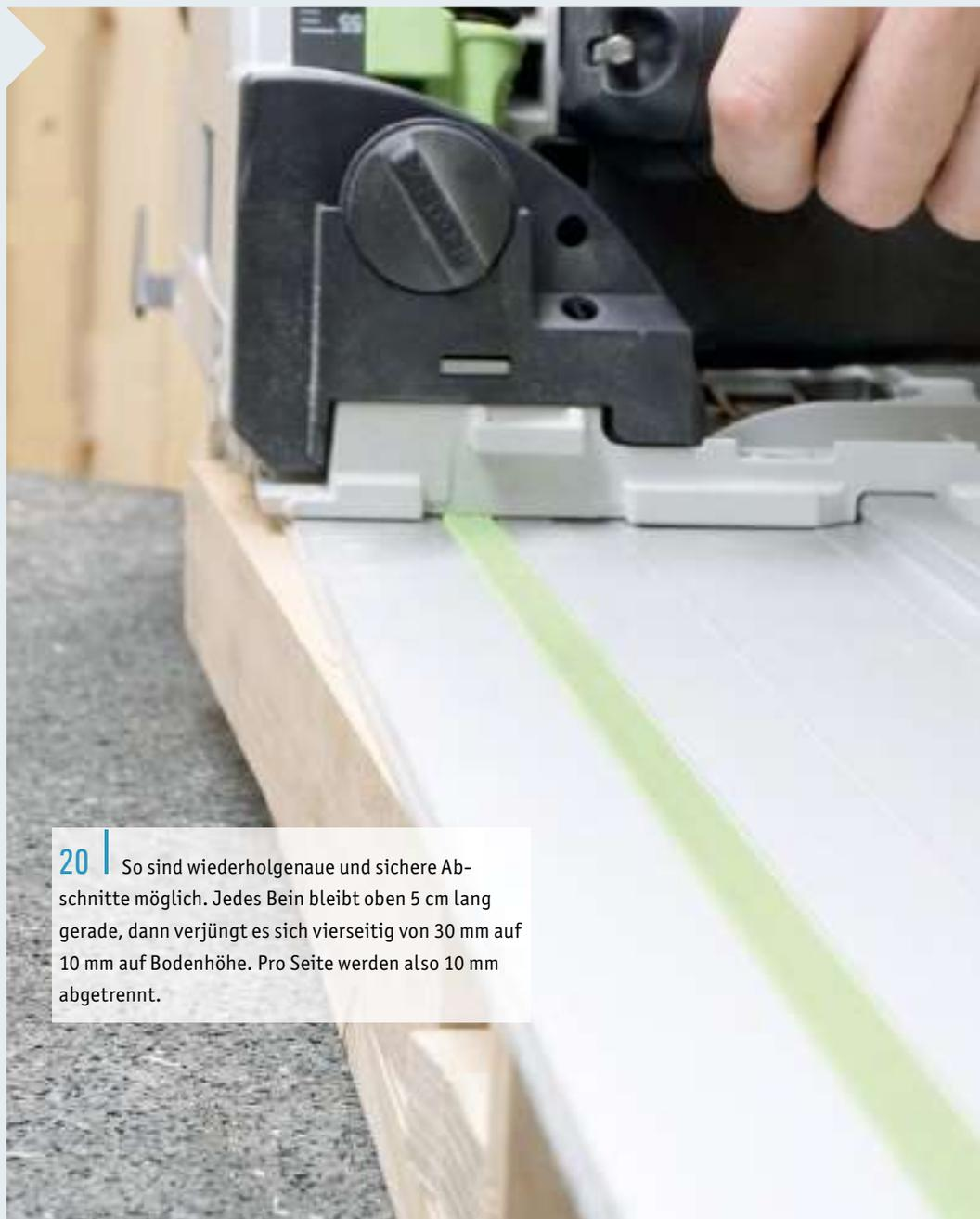
**20** | So sind wiederholgenaue und sichere Abschnitte möglich. Jedes Bein bleibt oben 5 cm lang gerade, dann verjüngt es sich vierseitig von 30 mm auf 10 mm auf Bodenhöhe. Pro Seite werden also 10 mm abgetrennt.
