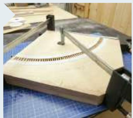
**8** Es kann gepresst werden: Nachdem an beiden Seiten das Furnier angelegt wurde, wird zunächst mit der mittleren Zwinge die Form geschlossen. Mit den beiden seitlichen Zwingen kann ein eventueller Höhenversatz korrigiert werden.
