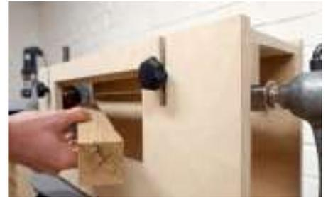
Durch die seitliche Öffnung ist das Bestücken der Drehselbank problemlos möglich. Das Werkstück ist dennoch durch die Vorrichtung zu großen Teilen abgedeckt und erlaubt ein sicheres Arbeiten.
