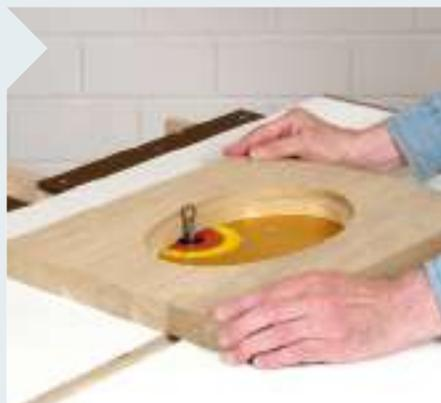
**4** Den inneren Ellipsen-Ausschnitt sägen Sie zuerst wieder grob mit der Stichsäge heraus. Den restlichen Überstand übernimmt dann der Bündigfräser.
