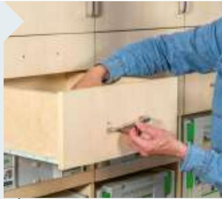
**4** | In den 4,5-mm-Bohrungen haben die M4-Flachkopfschrauben noch etwas Spiel, so dass man die Griffe, falls nötig, noch etwas ausrichten kann.
