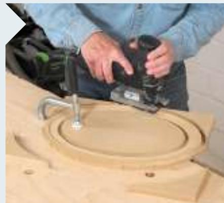
**6** Wenn die gewünschte Profilform fertig ist, sägen Sie die Außenecken und den Innenteil des Rahmens grob mit der Stichsäge aus.
