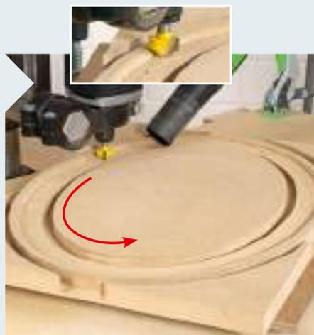
**5** Die Rahmenfläche lässt sich bei Bedarf auch noch sehr gut mit stirnschneidenden Profilfräsern (hier ein Abrundfräser) bearbeiten. Dabei möglichst immer im Gegenlauf arbeiten (Pfeil).
