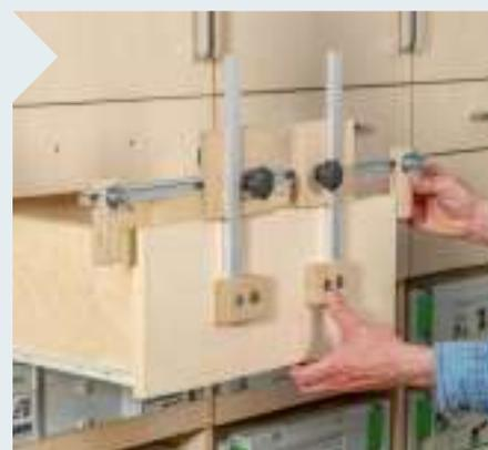
**2** | Richten Sie jetzt die Bohrlehre mittig über der Schubkastenblende aus und stoßen Sie die beiden Seitenansschläge gegen die Blendenkanten.
