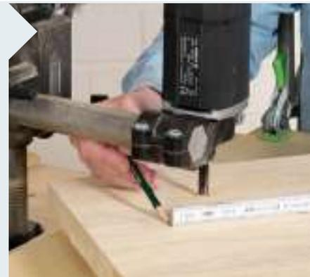
**2** Jetzt markieren Sie sich die Länge der Haupt- und Nebenachse (Ausschnittgröße) und stellen den Auslegerarm samt Maschine und Nutfräser darauf ein.
