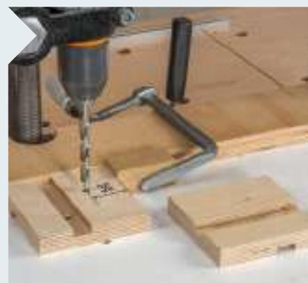
**5** Mittig durch alle Nuten bohren Sie auf dem Bohrstander ein 8,5-mm-Loch für die Sechskantschrauben. Der Abstand von der Außenkante beträgt 35 mm.
