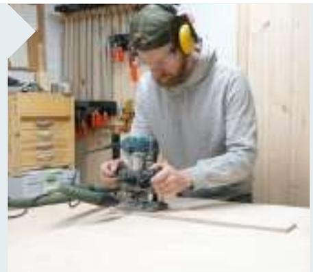
**2** Das weiche Holz der Stabsper Holzplatte kann selbst eine kleine Oberfräse gut zerspannen. Um lästigen Kabelsalat bei der Drehbewegung zu vermeiden, führen Sie die Oberfräse drehbar in einem Kopiering.
