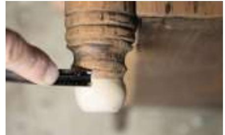
Die Kugel wurde passend abgesägt und mit Dübeln verbunden. So ergänzt, bekommt der alte Fuß wieder seine ursprüngliche Festigkeit und seine kugelige Gestalt zurück.
