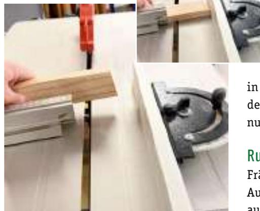
Drehen Sie das Holz einfach nach jedem Schnitt um – so können Sie immer wieder gleich lange Trapeze schneiden.
