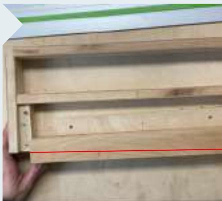
**18** | Klemmen Sie den Beinrohling ein und schneiden und richten Sie ihn dabei aus. Später, beim zweiten Schnitt, drehen Sie das Bein um 90° und nutzen das Abfallstück des ersten Schnitts als stützende Zulage.
