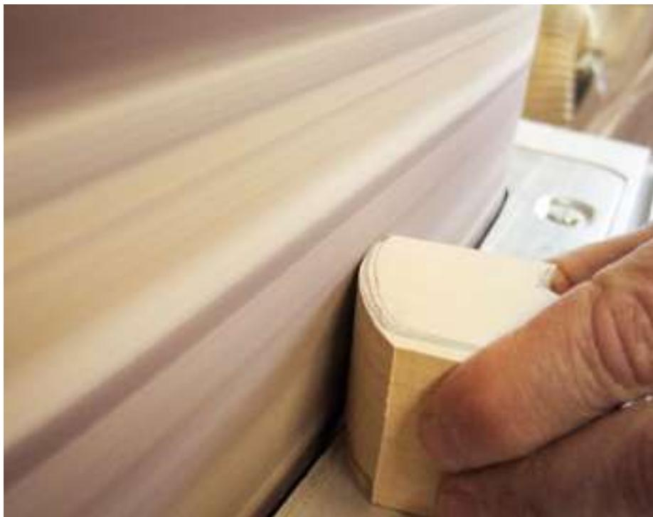
Eine Band- und Tellerschleifmaschine ist hilfreich beim Schleifen der Rundungen. Es funktioniert aber auch per Hand mit Feilen und Schleifpapier.
