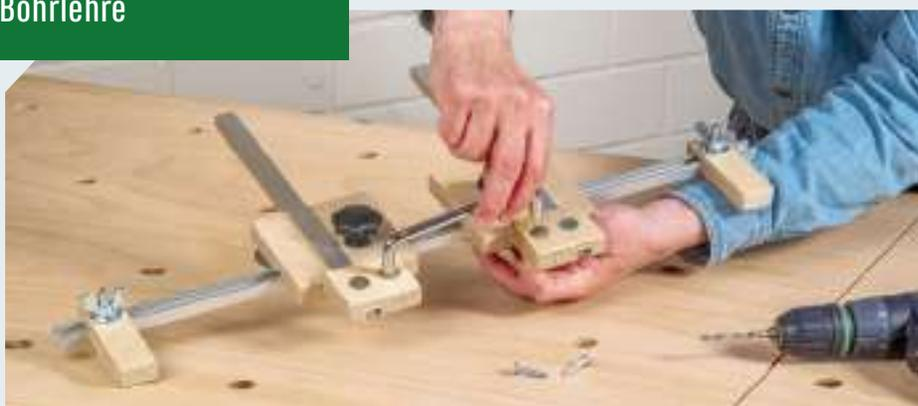
**1** | Mithilfe des Möbelgriffs als Abstandhalter stellen Sie die beiden Bohrköpfe ein. Ein Meterstab ist nicht nötig und so können auch keine Messfehler entstehen. Im nächsten Schritt stellen Sie den gewünschten Abstand der beiden Bohrköpfe zum Verschiebekreuz ein.
