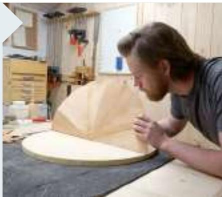
**15** | Der Mittelpunkt der Furnierfläche wird genau an die Plattenmitte gesetzt. Nun wird zunächst die erste Fläche mit Leim bestrichen, umgeklappt und die nächste Hälfte folgt. Die bereits furnierte Kante ist als Leimschutz rundum mit leicht lösbarem Kreppband abgeklebt.
