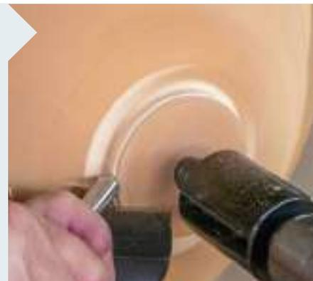
**7** | Gehen Sie es mit einer Drehzahl von 600 U/min gemächlich an. Geben Sie zunächst mit der 13-mm-Schalenröhre und dem liegend eingesetzten Flachmeißel (für die Innenecke) dem Zapfen seine runde Form zurück.
