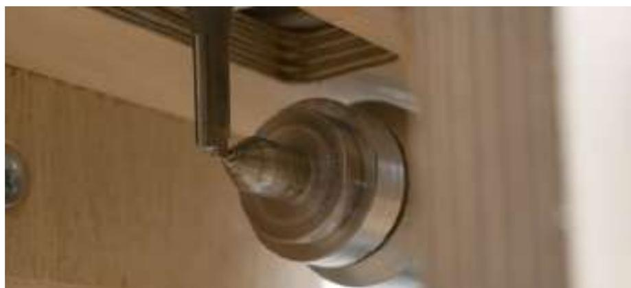
Im besten Fall fluchtet der Mittelpunkt des Fräasers mit der Drehachse der Bank, kontrolliert sowohl beim Mitnehmer als auch bei der mitlaufenden Körnerspitze. Ungenauigkeit wird durch leichtes Verschieben der Auflageklötze des Oberfräsenbretts über die Schlitze behoben.
