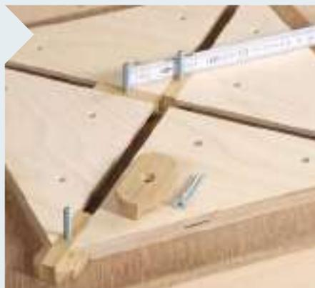
**4** Sägen Sie zwei 50 mm lange Stücke von der Gleitleiste ab. Bohren Sie mittig ein 5-mm-Durchgangsloch für die M5x40er Senkkopfschraube (Bohrung gut ansenken) und schrägen Sie die Enden noch auf 45° ab.
