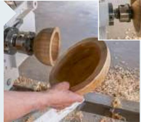
**3** | Variante 1: Drechseln Sie im Backenfutter ein Hilfsstück, wie eine einfache, aber dickwandige Schale geformt. Setzen Sie den Schalenrohling mit seiner Öffnung darauf, richten Sie ihn aus und pressen Sie ihn mit dem Reitstock kräftig an.
