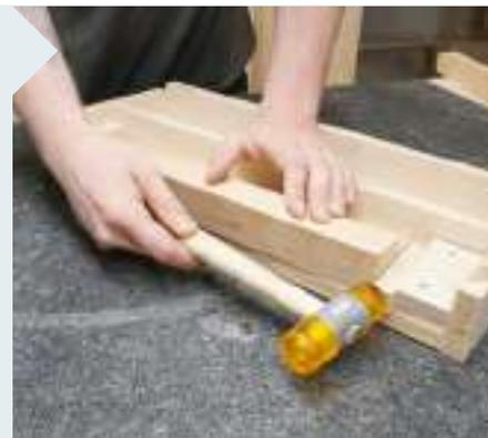
**17** | Zu den Beinen: Diese Vorrichtung hält das Bein für die Schrägschnitte mit der Tauchsäge: Das Kantholz ist angelegt und wird mit einem Keil fixiert. Das hintere Brett ist leicht erhöht und dient als Anschlag für die Führungsschiene.
