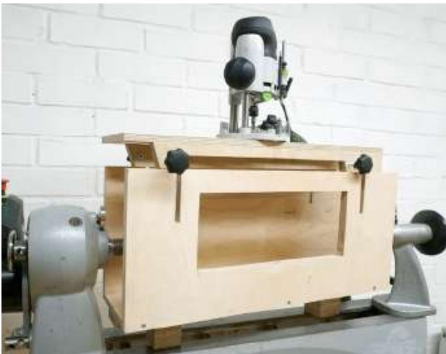
Die Vorrichtung: Der Deckel samt Oberfräse passt in die aufrechten Nuten. Er wird mit Sterngriffen arretiert: Parallel zur Dreh-Achse (für Zylinder) oder auf einer Seite gesenkt (für Konus-Formen).
