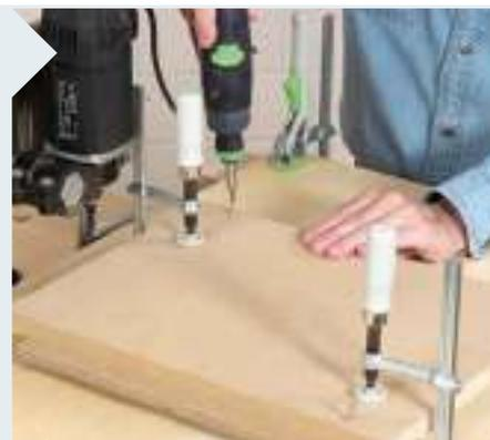
**3** Zu Testzwecken können Sie auch sehr gut eine 19 mm dicke MDF-Platte (hier 400 x 310 mm) verwenden, die Sie einfach mit zwei Schrauben am Drehteller befestigen.
