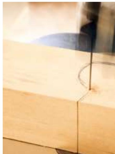
Ein intaktes Bein dient als Vorlage, deren Rohling nur minimal stärker ausgehöhelt sein sollte als das alte Holzmaterial. Die Form lässt sich mit einer Dekupiersäge sauber sägen, aber am unteren Ende sollten Sie noch Holzmaterial zum Ablängen belassen.
