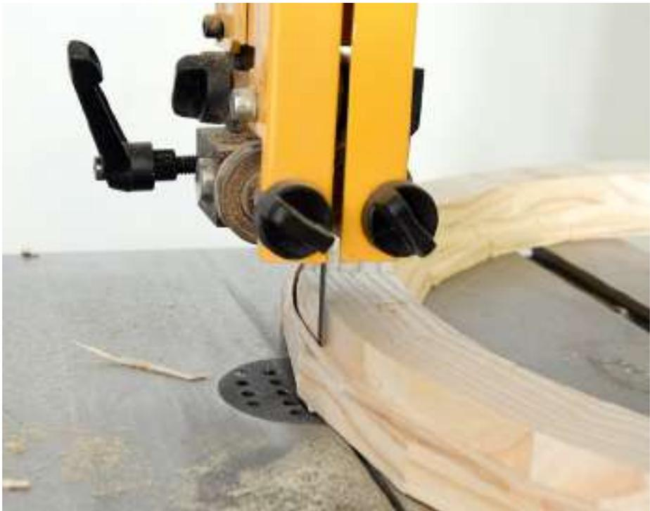
Die Überstände außen können Sie grob an der Bandsäge entfernen, die im Inneren mit der Stichsäge. Achten Sie darauf, nicht zu weit einzusägen: Der bereits gefräste Radius ist tabu.
