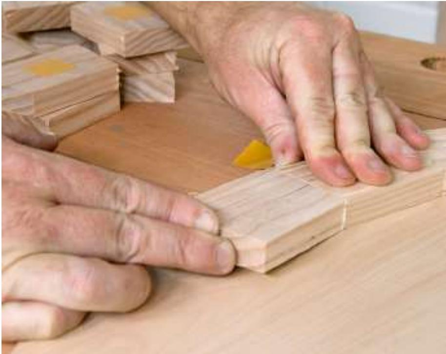
Das erste Zwanzigeck wird auf einer Trägerplatte aus Hartfaser (Radius etwas größer als der angestrebte äußere Ringradius, hier 275 mm) fixiert. Nutzen Sie dafür einen kleinen Streifen doppelseitiges Klebeband pro Segment. Die Stirnseiten sind verleimt, um kleine Spalte zu schließen.
