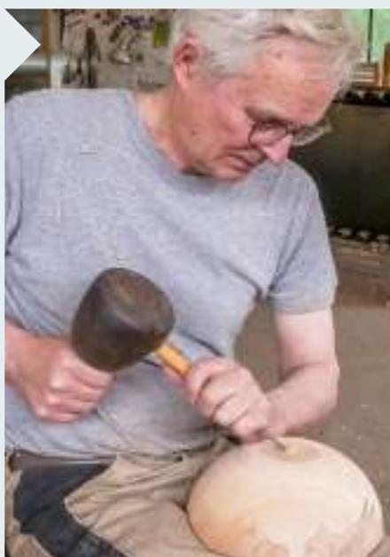
**17** | Den Ansatz in der Mitte können Sie mit Hilfe sehr viel aufwändiger Technik entfernen (Planscheibensegmente, Longworth-Futter, Vakuum). Oder Sie greifen zu einem flachen Hohlisen, stemmen ihn innerhalb einer Minute ab und verschleifen die Stelle: Fertig!
