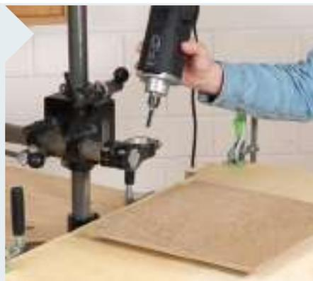
**2** In einen Fräsmotor mit 43-mm-Eurohalsaufnahme spannen Sie als Erstes einen 10 mm Nutfräser ein. Anschließend befestigen Sie die Maschine im Bohrständler.
