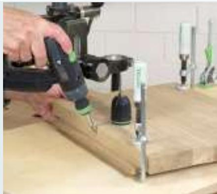
**1** Hat die Platte genügend Übermaß, kann sie bequem und sicher an den Seiten mit je einer Schraube auf dem Drehteller befestigt werden. Dafür unbedingt schräg vorbohren!
