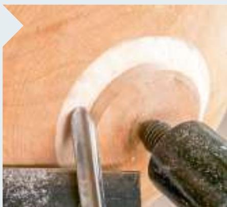
**8** | Ein Standbild zur Erläuterung: Die Schalenröhre mit Fingernagelschliff muss (am Reitstock vorbei) anders ansetzen als normal. Das Heft liegt am Bankbett an, das Eisen weist fast senkrecht hoch. Mit anliegender Fase wird der Schnitt sehr sauber.
