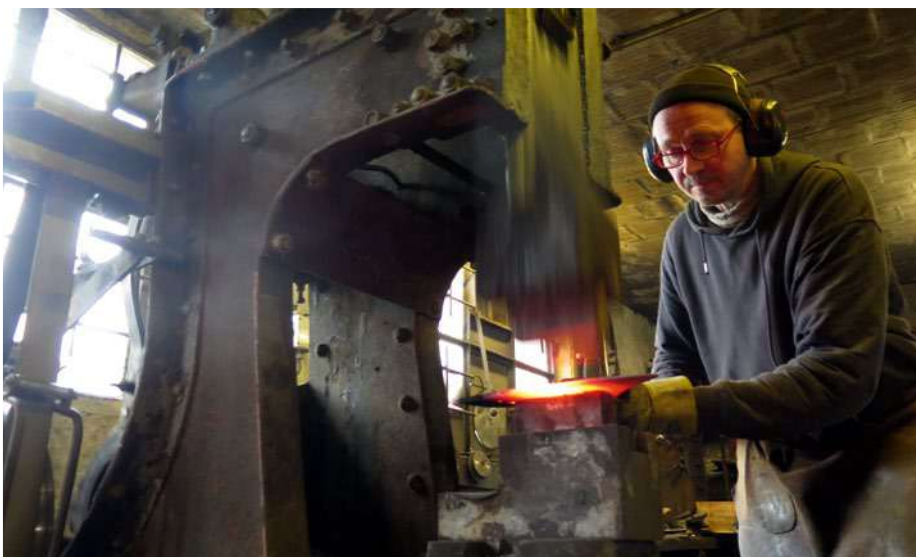
Dieser Hammer, auch Golem genannt, ist gut 100 Jahre alt und wird immer noch über Transmission mit einem breiten Lederriemen angetrieben. Hier und am Amboss schmiedet Maas gerade die Klinge eines Beils aus.
