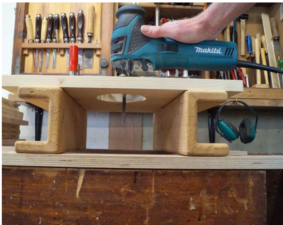
Eine Stichsäge braucht Freiraum unter dem Holz – mit den C-Böcken kein Problem. Und wenn sie doch mal Kontakt zum Sägeblatt haben? Auch nicht schlimm – sie sind aus Holz.
