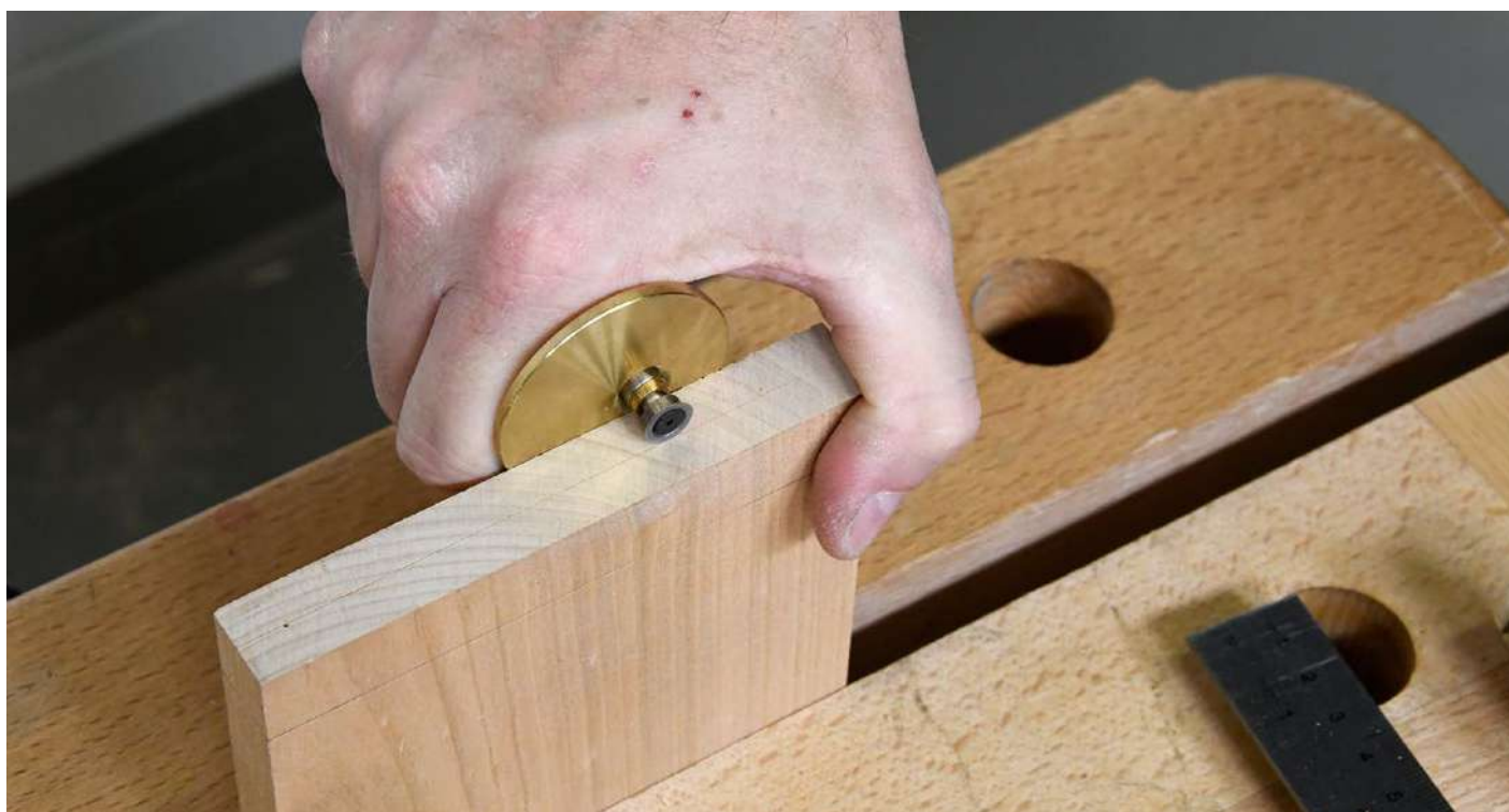
1 | Reißen Sie mit einem Streichmaß eine Mittellinie auf das Hirnholz des Schwalbenbretts. Sie wird der Spazierweg für die Zirkel.
