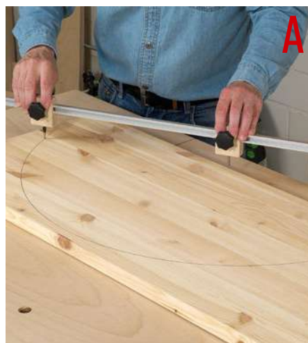
Teil 1: Mit diesem Stangenzirkel lassen sich, je nach Länge der T-Nut-Schiene, Radien von 50 bis 2.550 mm präzise anzeichnen. Aber das Beste: Der Nachbau dauert weniger als eine Stunde!
