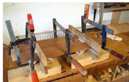
Müssen beim Verleimen von Flächen die Hölzer durch Leisten gerade gehalten werden, stören die Zwingen. Hier verschwinden sie zwischen den C-Böcken. Die Halteleisten liegen trotzdem plan auf und schaffen eine gerade Fläche.
