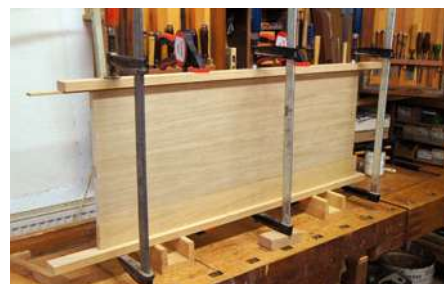
Große Platten mit Anleimern auszustatten gehört dank C-Böcken nicht mehr zu den nervigen Arbeiten. Beim Ansetzen der Zwingen rutscht der Anleimer nicht nach unten weg. Senkrecht aufgestellt braucht die Platte während der Trocknungsphase nicht mehr viel Platz.
