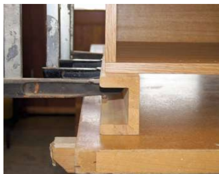
Die C-Böcke liefern neben sicherem Stand zugleich dort Zulagen, wo sie gebraucht werden. Die Zwingen können genau dort drücken, wo die Teile aufeinandertreffen. Gerade angesetzte Zwingen ermöglichen eine winklige Verleimung des Korpus.
