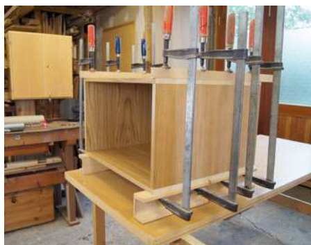
Ein sperriger Korpus findet beim Verleimen auf vier C-Böcken sicheren Stand. Auf die zuerst aufgelegte Seite werden, nach Leimangabe und Setzen der Verbinder, die weiteren Teile aufgebaut. Am Ende bringen die Zwingen den nötigen Pressdruck.
