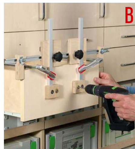
Teil 2: Pass- und wiederholgenaue Befestigungslöcher für alle Arten von Möbelgriffen und -knöpfen werden mit dieser Bohrlehre zum Kinderspiel.
