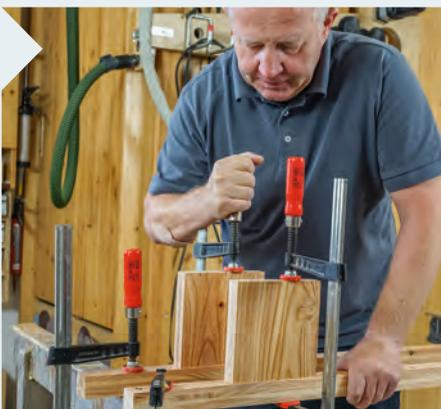
**10** | Die Fußbretter werden mittig über der Bohrung ausgerichtet und mit Schraubzwingen fixiert.
