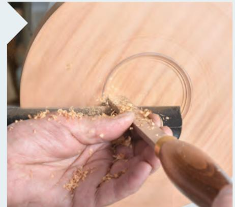
**9** Formen Sie im nächsten Schritt mit einem liegenden Schaber den Rand so aus, dass Ihr Futterbacken-Modell später perfekten Grip bekommt. Also je nach Bauart gerade (achsparell) oder schräg (bei schwalbenschwanzförmigen Backen).
