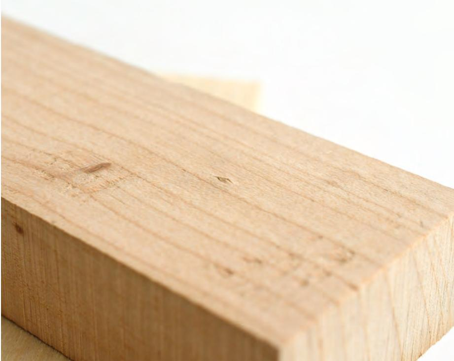
Die Schraube baut nicht nur seitlichen Druck auf, auch unter der Spitze wird das Holz komprimiert: Die Schraube zeichnet sich auf der Gegenseite ab, selbst wenn sie die Oberfläche nicht durchdringt. 3 mm Holz sollten deshalb immer mindestens unter der Schraubenspitze verbleiben.
