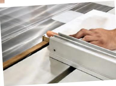
Felder hat seiner Kappa 550 mit einer Magnetfeldüberwachung ein zerstörungsfreies Sägestop-System verpasst, um Verletzungen zu vermeiden. Auch Altendorf setzt mit dem „Hand Guard“ auf eine Schnellabsenkung, arbeitet aber mit Kameras. Beide Systeme zogen viele Blicke auf sich und sollen in den nächsten Jahren Standard werden.
