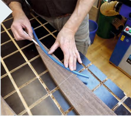
**13** Die Füße entstehen aus dem Reststück des Ständers. Ein Kurvenlineal ist sehr praktisch zum Ermitteln der Form. Danach zuerst nur die obere Rundung der Füße aussägen. Sägen Sie die unteren Rundungen erst nach dem Ansägen der Gehrungen am hinteren Fußende!
