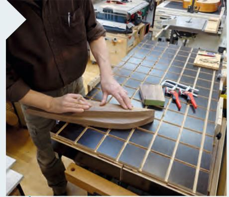
**15** Der zuerst fertig ausgesägte Fuß dient als Vorlage für den zweiten Fuß.
