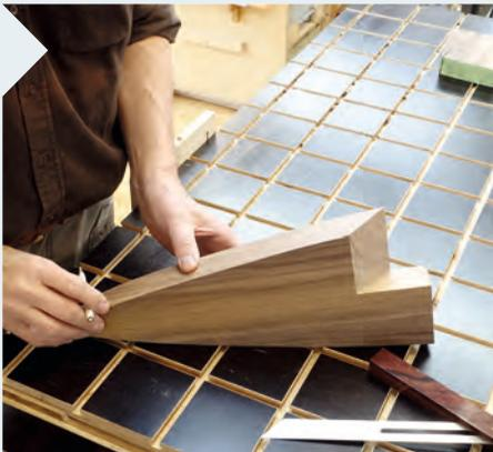
**16** Sägen Sie den oberen Bogen des zweiten Fußes. Anschließend wird dessen genaue Zugschnittlänge durch Auflegen des ersten Fußes ermittelt. Zur Erinnerung: den unteren Bogen erst zum Schluss aussägen. Das schräge Fußende muss gespiegelt zum ersten Fuß sein.
