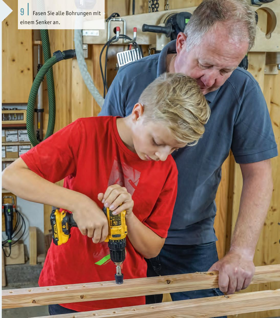
**9** | Fasen Sie alle Bohrungen mit einem Senker an.
