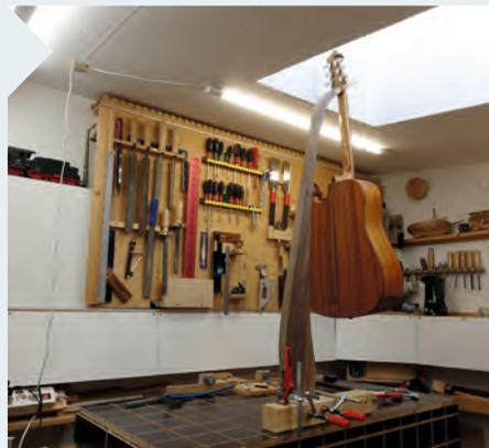
**11** Mit der eingehängten Gitarre ermitteln Sie die Länge und die Neigung des Ständers. Dabei muss man nach Augenmaß arbeiten. Ein Kantholz markiert die Schnittlinie, an welcher der jetzt noch zu lange Ständer gekürzt wird.
