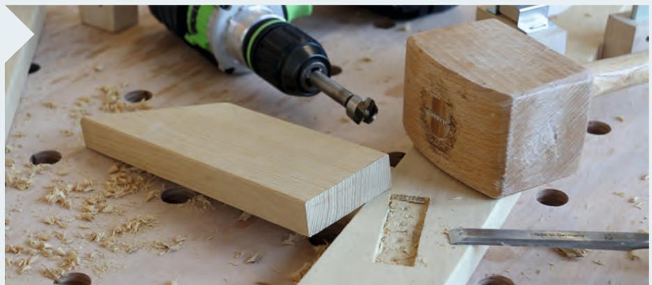
**19** | Nach der Montage der Bauteile 5, 2, 11 und 12 zu einem „U“ werden nun die Nuten erstellt, die die Träger für die oberen Regalbretter (Pos. 7) tragen werden. Die Pos. 11 und 12 werden vor die Hirnhölzenden geklebt, so dass weniger Regenwasser in die Hirnhölzer eindringen kann.
