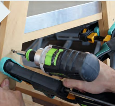
**21** | Nun kann der Träger von hinten an das Unterteil geschraubt werden. Einhandzwingen halten während des Bohrens und Verschraubens den Träger in Position. Durch diese Konstruktion wird die Metall-Tischdecke hinten fixiert.
