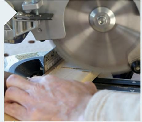
**8** Zur Erstellung der Nuten in den Bauteilen eignet sich die Zug-Kapp-Gehrungssäge hervorragend. Das Einstellen der genauen Schnitttiefe auf halbe Materialstärke braucht einige Einstellversuche und Probeschnitte, dann geht es aber zügig voran.
