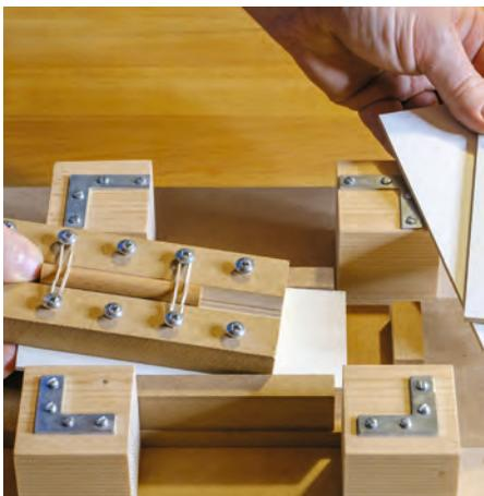
Werkstücke unterschiedlicher Dicke lassen sich mit Beilagen auf die richtige Höhe bringen. Ein Feinabgleich kann mit Papp- oder Furnierstreifen vorgenommen werden. Abweichungen von einigen Zehntel Millimetern spielen keine Rolle.
