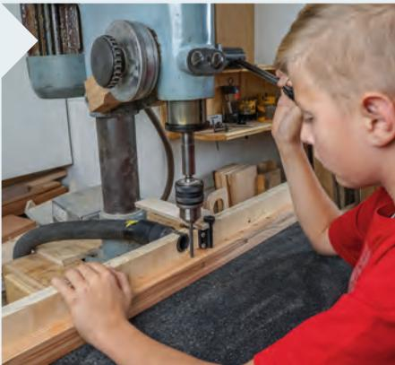
**8** | Auch die Reihenbohrungen werden beidseitig ausgeführt. Sicher ist sicher, während des Umdrehens und der Rastbolzenbetätigung (siehe Kasten S. 55) immer die Maschine ausschalten.
