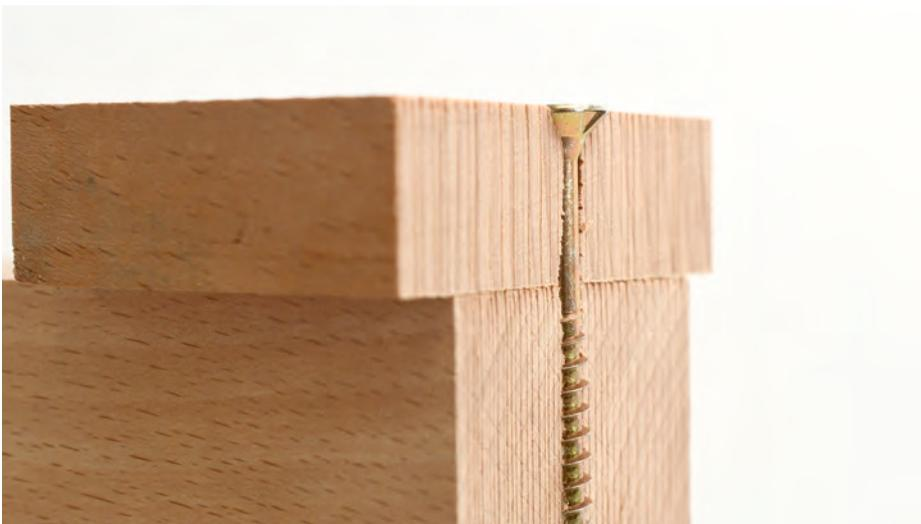
Das Funktionsprinzip eines Teilgewindes im Detail: Es wird deutlich, warum das Loch im oberen Brett in Schraubenstärke gebohrt werden sollte.
