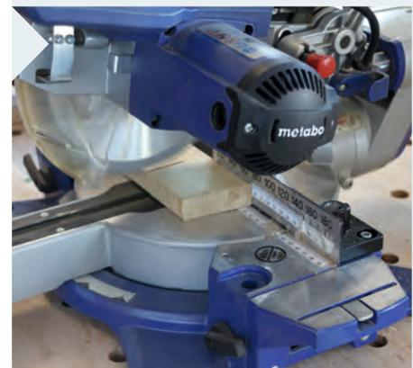
**5** Schließlich werden die einzelnen Bauteile aus den gesägten und gehobelten Streifen mit der Zug-Kappsäge abgelängt. Hier macht sich das vorherige Festlegen der Bauteile auf den Bohlen bezahlt. Wer sauber vorgezeichnet hat, produziert nun weniger Reststücke.
