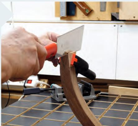
**10** Ein kleiner, angeklebter Klotz zur Führung erleichtert das Ansetzen der Säge. Verwenden Sie zuerst die feine Zahnung zum Ansägen, danach die gröbere für Längsschnitte. Die Gabel kann dann bereits eingeleimt werden.
