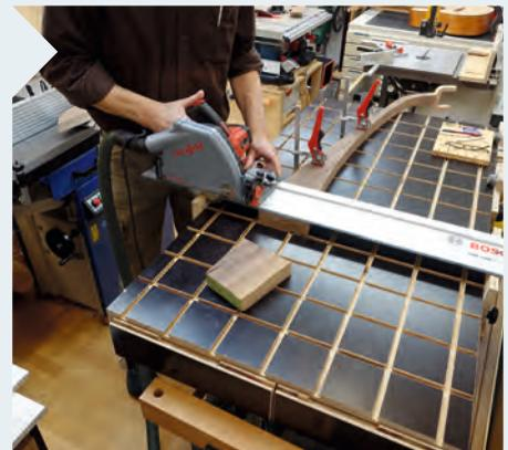
**12** Da die Schnittlinie nicht rechtwinklig zur Werkstückkante läuft, klappt das Kürzen am besten mit Handkreissäge und Führungsschiene.
