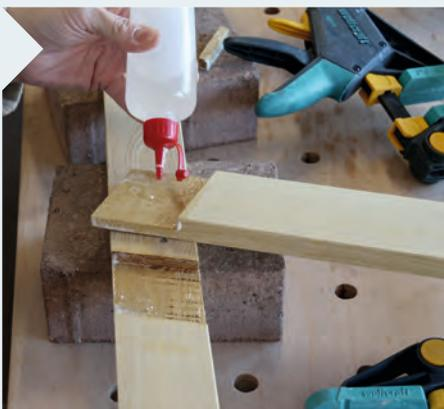
**12** Sind alle Überblattungen erstellt und alle Verbindungen der einzelnen Bauteile zueinander auf ihren guten Sitz geprüft, werden die Bauteile miteinander verleimt. Zum Einsatz kommt hier ein PUR-Kleber, der auf allen Kontaktflächen großzügig aufgetragen wird.
