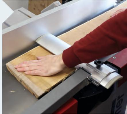
**2** Nun ist bekannt aus welcher Bohle welches Bauteil geschnitten wird. Jetzt beginnt das Abrichten und Aushobeln der Bohlen auf die endgültige Materialstärke.
