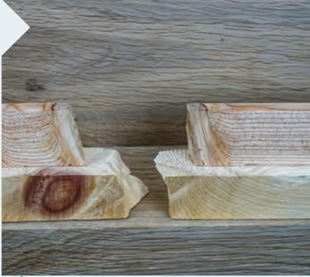
**1** Auf den ersten Blick kaum zu erkennende Wachstumsfehler. Würden die Stangen der Stelzen aus nur einem Stück bestehen, könnten solche Bruchstellen zu einer großen Gefahr werden.
