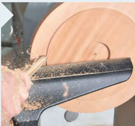
**11** Nach dem Schleifen ist die Unterseite fertig. Sie können den Rohling umdrehen und mit dem zuvor gedrehten Rezzes in den großen Futterbacken aufnehmen. Dann heißt es zunächst einmal wieder: plan drehen.
