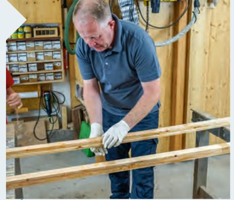
**3** In gleichmäßigen Abständen um das Leistenpaket gelegte Klebebandstreifen verhindern ein Verrutschen während des Verleimens.
