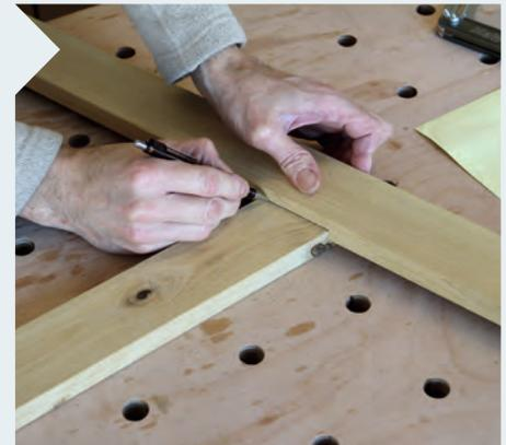
**11** Nachdem die Nuten in der Mitte der Bauteile erstellt wurden, dienen diese Nuten nun als Zeichenhilfe für die jeweiligen Überblattungen an den Enden der entsprechenden Bauteile. Auch hier hilft der spitze Bleistift.
