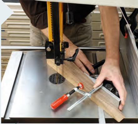
**14** Das hintere Fußende wird im 50°-Winkel angesägt. Klemmen Sie das Werkstück sehr gut fest. Sägen Sie anschließend die untere Rundung aus.
