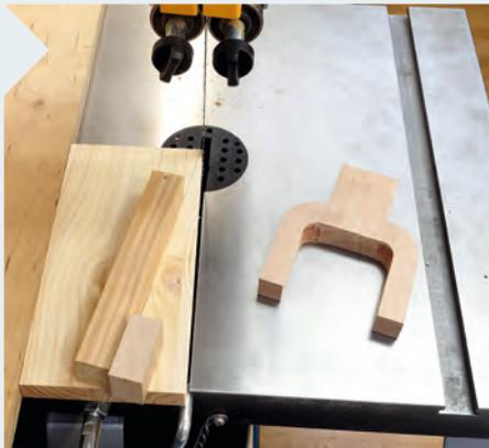
**8** Eine einfache Führung zum keilförmigen Ansägen des Zapfens wird aus einer rechteckigen Unterlage, einer kurzen Leiste und einem Stoppklotz selbst hergestellt. Klemmen Sie die Gabel mit einer Zwinde gut an und sägen Sie den Zapfen zweiseitig an.
