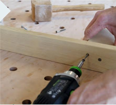
**20** | Wenn die Träger (Pos. 7) in die Nuten passen, schrauben Sie sie von hinten in vorgebohrte Löcher.
