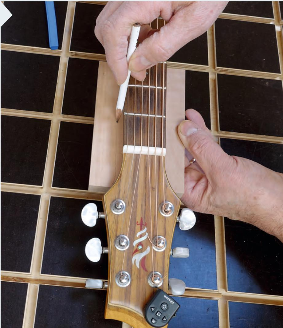
**4** Der Gitarrenhals dient als Vorlage zur Ermittlung der Öffnung der Gabel. Konzertgitarren haben einen breiteren Hals als die hier verwendete Westergitarre. Damit auch diese passen, ist diese Gabel entsprechend größer bemessen.
