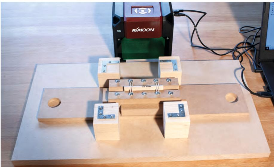
Eine Eigenbau-Vorrichtung mit Schieber, auf welcher der Laser steht, erleichtert das Gravieren von Schreibgeräten. Diese liegen in einer V-förmigen Nut und werden durch Gummibänder in Position gehalten.
