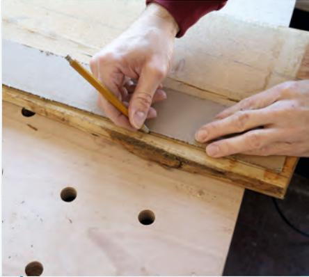
**1** Nach dem Einkauf beim Holzhändler werden die Bohlen auf die Werkbank gelegt und die einzelnen Bauteile grob mit viel Schnitzzugaben auf das Holz gezeichnet. Kartonstreifen, zugeschnitten in den Endmaßen, hilft beim Anzeichnen.
