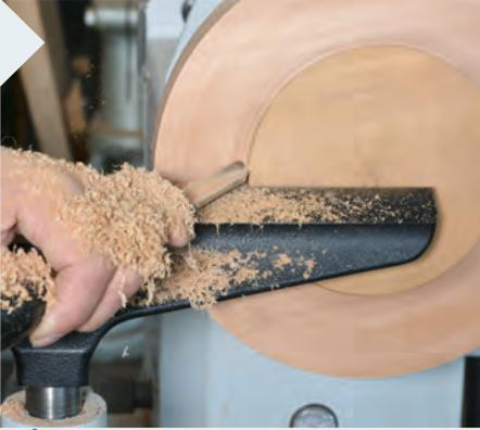
**5** Ebenfalls mit der Röhre drehen Sie die Tellerfläche nun in etwa plan. Führen Sie die Röhre dazu von außen hin zum Mittelpunkt. Nutzen Sie möglichst eine lange Handauflage, auf die Sie ihren linken Unterarm stützen können.
