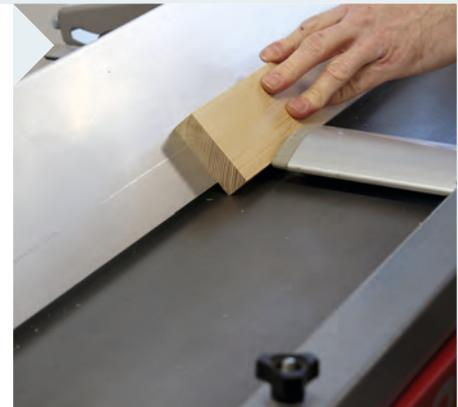
**4** Die auf Endmaß gesägten Streifen werden nun an den Längsseiten gefast. Dazu wird der Längsanschlag der Abrichte um 45° gekippt und die Kanten so darüber geführt. Alternativ kann diese Arbeit auch mit dem Handhobel oder Oberfräse erledigt werden.
