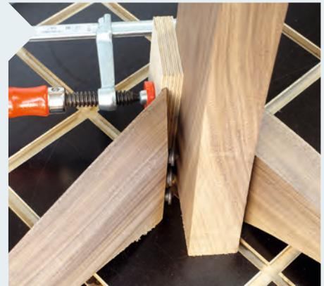
**18** Das Übertragen der Lochpositionen am Ständer klappt durch die Verwendung von Markierspitzen. Ein angeklebter Klotz sorgt für die exakte Position des Fußes. Auch hier 21 mm tief bohren.
