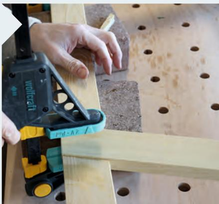
**13** Schließlich werden die einzelnen Kontaktstellen (hier Pos. 1 und Pos. 3) zusammengefügt und miteinander verpresst. PUR-Kleber hat eine sehr gute Haltbarkeit im Außenbereich.
