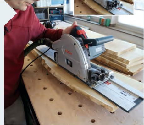
**3** Sind alle Bohlen gehobelt, werden sie mit der geführten Handkreissäge in Streifen von 82 mm Breite geschnitten. Die Zugabe von zwei Millimetern an den Streifen wird später am Dickenhobel noch abgehobelt.
