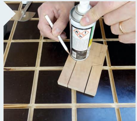
**5** Der Zapfen ist hier bereits an der Bandsäge angesägt. Eine runde Form (zum Beispiel von einer Sprühdose) dient zum Anreißen der Außenform der Gabel. Danach erfolgt der Innenausschnitt.
