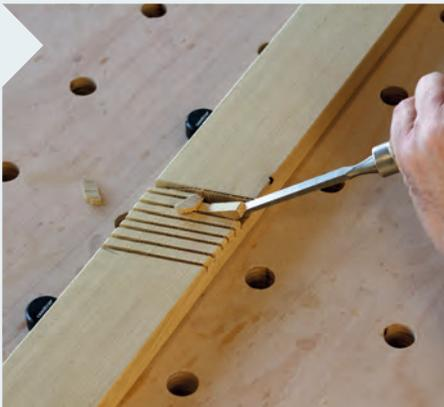
**9** Nach dem Nuten mit der Zug-Kapp-Gehrungssäge werden noch die verbliebenen Stege mit dem Stechbeitel entfernt.
