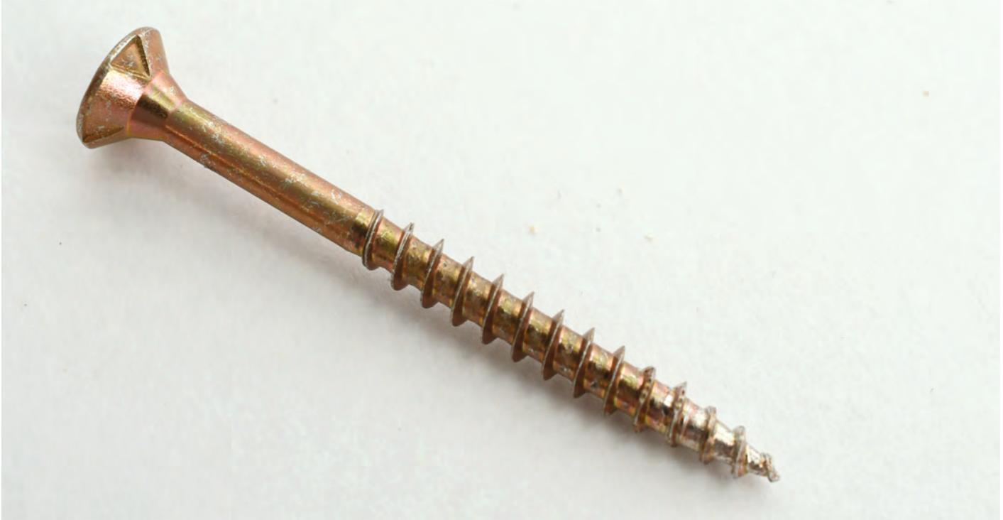
Prinzipiell spricht nichts dagegen, Schrauben wiederzuverwenden. Allerdings verliert eine öfter eingedrehte Schraube einen Teil ihrer Oberflächenbeschichtung, wie die blanke Spitze hier zeigt. Bei Beschädigungen im Antrieb oder Gewinde sowie bei Schrauben, die starken Belastungen ausgesetzt waren, sollte Sie diese aber immer ersetzen.
