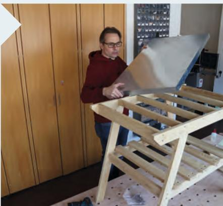
**18** | Die Pos. 8 und 9 dienen als Unterstützung der Tischfläche. Beide Teile werden mit Edelstahlschrauben in vorgebohrte und gesenkte Löcher mit den Beinen verschraubt. Legen Sie dann die Metallfläche auf und verschrauben sie auf der Vorderseite mit dem Bein.
