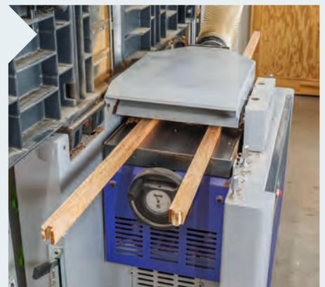
**6** Die Hobelmaschine bringt die Stangen auf ein einheitliches Maß von 36 x 36 mm.
