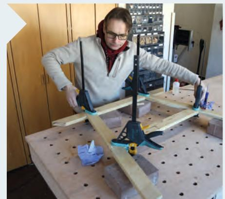
**14** Zum besseren Verzwingen werden die Bauteile (hier Pos. 1) auf Unterlagen gelegt. So können die Zwingen auch unter die Bauteile greifen. Die querverlaufenden Bauteile (Pos. 3 und 5) kommen so an ihre Plätze. Wichtig: Alles muss in einer Ebene liegen.
