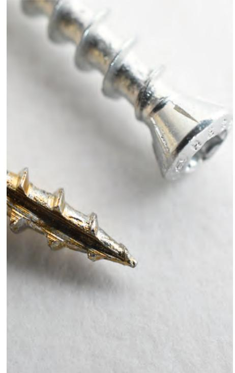
Einige Schrauben verfügen an der Spitze über einfache Vorbohrer, die das Spaltpotential reduzieren, aber nicht ausschließen. Schmalere Köpfe wie bei Parkettschrauben senken das Spalt-Risiko zusätzlich. In Hartholz müssen Sie aber auch bei diesen Schrauben vorbohren.
