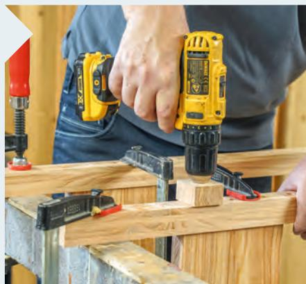
**11** | Durch einen Distanzklotz wird die Bohrtiefe bestimmt. Bei der mittigen Bohrung für die Gewindestange kommt ein 6-mm-Bohrer zum Einsatz.
