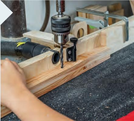
**7** | Beidseitiges Bohren verhindert Ausrisse auf der Werkstückunterseite. Für die erste Bohrung kommt ein Anschlagholz zum Einsatz.
