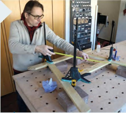
**15** | Damit die einzelnen montierten Bauteile später gut zusammenpassen, ist es wichtig, das Montierte zu messen und gegebenenfalls zu korrigieren. Die Rechtwinkligkeit des Bauteils kann durch das Erreichen der gleichlangen Diagonalen garantiert werden.
