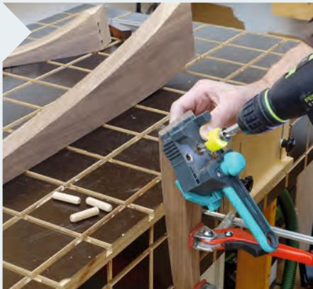
**17** Die 10-mm-Dübellöcher an den Füßen lassen sich gut mit einer Dübellöhre bohren. Die 21 mm tiefen Löcher müssen nahe am Rand sein. Weiter oben wäre das Holz zu dünn und es besteht die Gefahr des Durchbohrens.
