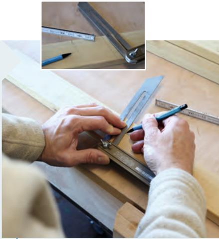
**7** Zeichnen Sie mittels Schmiege, Zollstock und feinem Bleistift die mittleren Überblattungen auf die Teile. Die Überblattungen an den Enden der Bauteile werden später angezeichnet.
