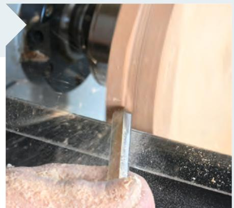
**4** Greifen Sie zu einer eher schmalen Schalenröhre (13 mm) und drehen Sie den offenen Bereich (Flute genannt) nach links. Suchen Sie den Schnitt, und führen Sie das Werkzeug nach links. Danach ist der Teller exakt kreisrund. ▶▶
