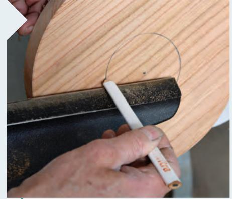
**7** Markieren Sie beim Rohling den Mittelpunkt und zeichnen Sie von diesem ausgehend den Radius (hier 44 mm) an. Ziel ist es, dass der nun folgende Rezzes rundum Kontakt mit dem Futter hat. So hält die Verbindung auch bei geringer Rezzes-Tiefe sehr gut.
