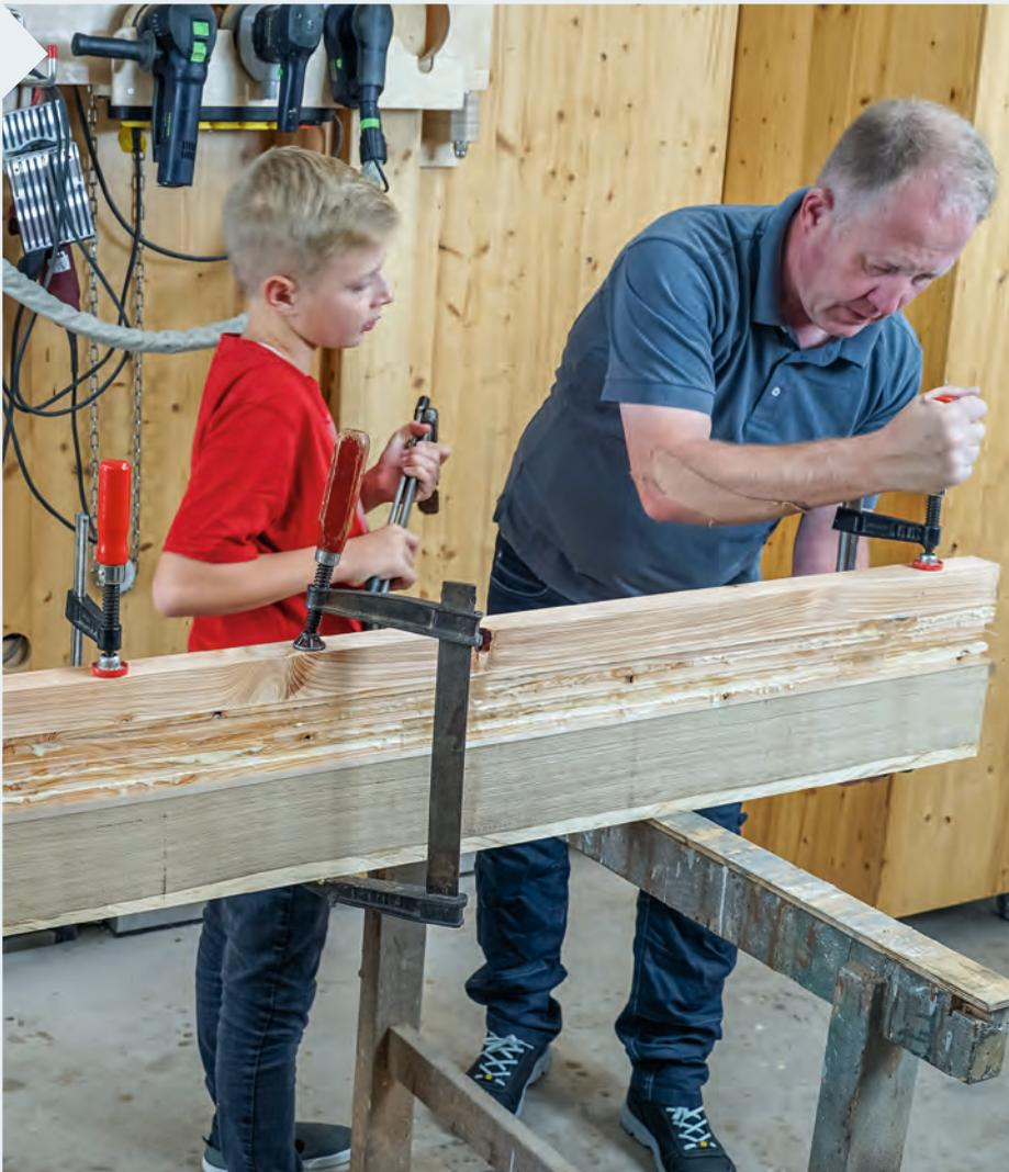
**4** Gerade und stabile Zulagen garantieren gerade Stangen. Achtung, die Trennschicht nicht vergessen.
