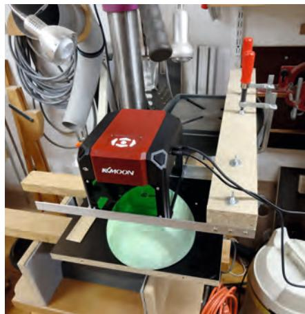
Die unten offene Bauform des Lasers ermöglicht es größere Objekte (wie etwa Schalen) zu gravieren. Der höhenverstellbare Tisch einer Säulenbohrmaschine lässt sich nutzen, um den Laser über dem Schalenboden auszurichten.
