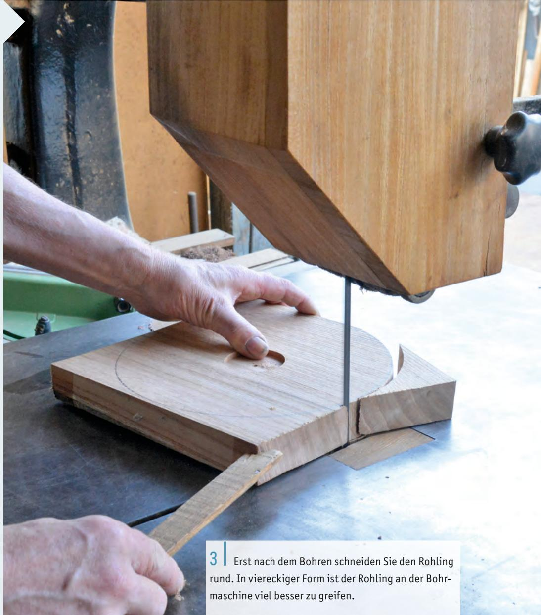
**3** Erst nach dem Bohren schneiden Sie den Rohling rund. In viereckiger Form ist der Rohling an der Bohrmaschine viel besser zu greifen.
