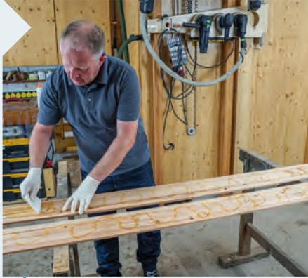
**2** Mit einem Zahnpachtel wird der PUR-Kleber aufgetragen. Ratsam ist es, den Leim beidseitig dünn aufzutragen. Dies verbessert die Haftungseigenschaften und führt zu einer stabileren Verleimung.
