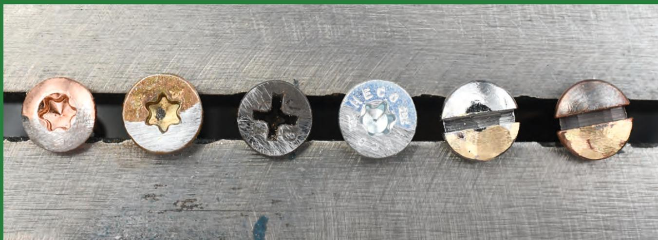
Wenige Züge mit der Feile zeigen: Die Beschichtung ist nur hauchdünn – reicht aber, um den Stahl oder das Messing (rechts, vernickelt und brüniert) vor Umwelteinflüssen wie Luftfeuchtigkeit zu schützen.
