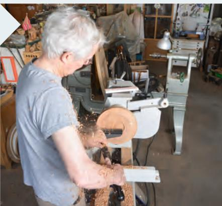
**10** Wieder mit der Röhre beginnen Sie nun, 30 mm vom Rezzes entfernt, die Schräge der Unterseite anzulegen. Am Rand dient eine Markierung bei 12 mm von unten als Ziel. Drechseln Sie alles zwischen den Markierungen weg, mit einer kleinen Hohlkehle am Standring.
