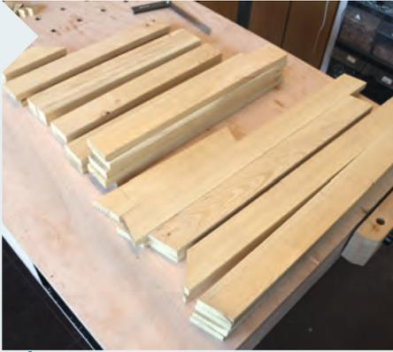
**6** Schließlich sind alle Bauteile auf Endmaß geschnitten. Die Gehrungen konnten dank der Zug-Kapp-Gehrungssäge auch präzise erstellt werden.
