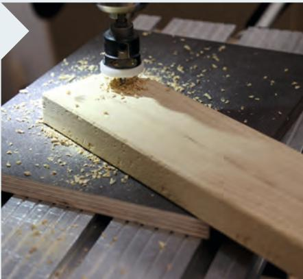
**16** | Robinie ist ein hartes Holz, dass sich ohne Vorbohren nicht sehr gut verschrauben lässt. Daher werden an den Pos. 6 die Schraub-löcher vorgebohrt und eingesenkt. Das geschieht am besten an der Standbohrmaschine.
