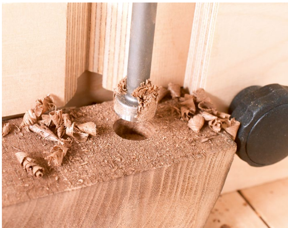
Nachteil: Gerade bei den dünnen Forstnerbohrern (hier 10 mm) ist die Arbeit zum Teil mühsam: Es geht langsam voran und der Bohrer verstopft oft.
