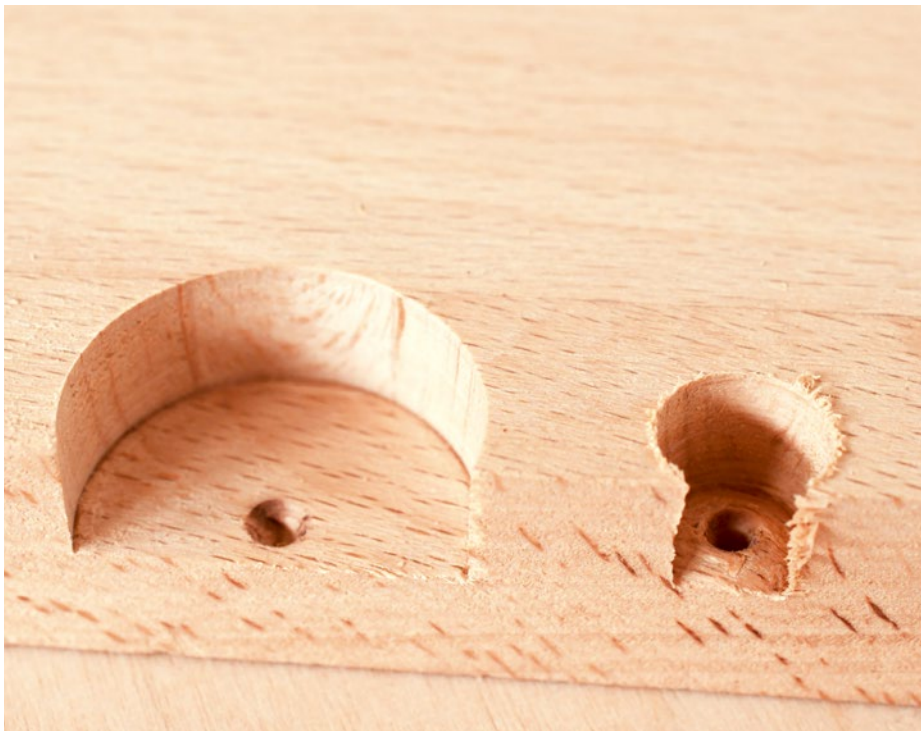
Im Vergleich zum Loch mit dem Holzspiralbohrer (rechts) sind die Löcher deutlich sauberer und ihre Kanten ausrissfrei.
