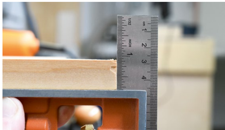
Gerader Schnitt: Die gesägte Kante verläuft rechtwinklig zur Fläche, auch in kurvenreichen Schnitten.
