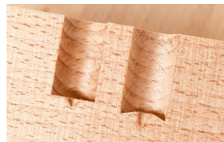
Das Ergebnis im Querschnitt, wieder im Vergleich zum Spiralbohrer (rechtes Loch): Die Wandung ist glatter, der Boden eben und der Abdruck der Zentrierspitze sehr klein.
