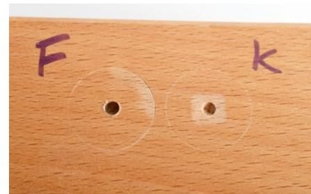
Der erste Kontakt der Schneiden ins Holz erfolgt beim Forstner- und auch beim Kunstbohrer (siehe Kasten Seite 16) mit den umlaufenden Schneiden. Sie zerteilen die Holzfasern, bevor die Hauptschneiden sie abnehmen.
