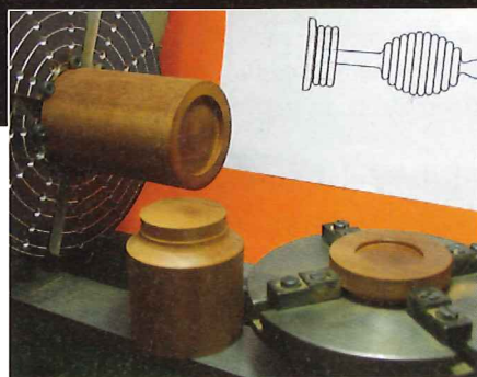
Ein passgenauer Zapfen, gedreht aus einem Stück Restholz, schont den Spund des Deckelchens und dient auch zum Drechseln des Zwischenbodens.
