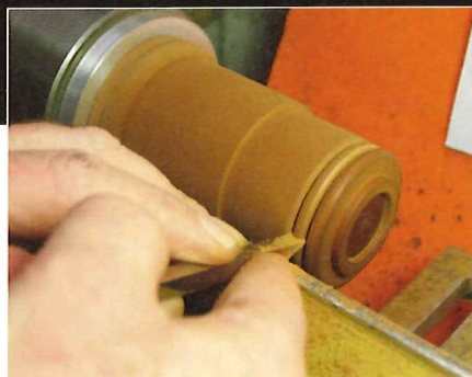
Die „Stäbe“ genannten halbrunden Profilierungen lassen sich mit einer Röhre andrehen oder wie hier im Bild mit einem angedrehten Profilstahl.
