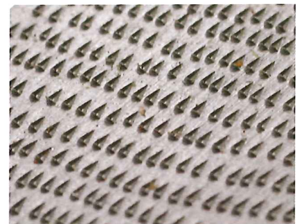
Bei Raspeln sind die Hiebe unregelmäßig auf der Werkzeugoberfläche verteilt, dadurch wird ein guter Abtrag erzielt.
