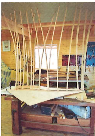
Ungeahnte Kräfte entwickeln die Latten des „Tischlerhimmels“ beim Verleimen.
