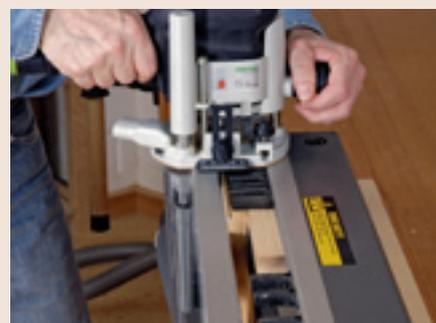
*Durch die beiden Schienen liegt die Fräse immer komplett auf und kann nicht kippen. Das bringt Sicherheit und erleichtert gute Verbindungen.*
