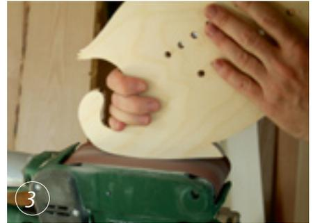
3 Mit Bandschleifer oder Feile werden Unebenheiten in der Kontur vor dem Aussägen der Schlitz- korrigiert.
