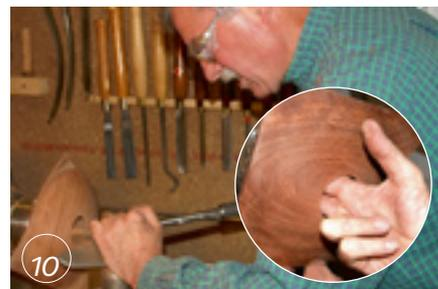
6 Jetzt geht es ans Innenleben: Die Dose am Unterteil aufspannen und das Innenteil aushöhlen. Ich benutze hierfür den „Spechtschnabel“ und den „Giraffenhals“, selbst hergestellte Werkzeuge. Diese Werkzeuge erzeugen feine Späne, die schnell ausgeblasen oder abgesaugt werden können.
