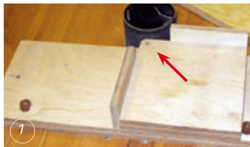
Die Schleifvorrichtung besteht aus einer Grundplatte, einer drehbar (Pfeil) gelagerten Werkstückhalterung samt zwei Anschlagknöpfen.
