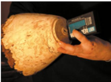
Moderne Messgeräte ermöglichen die Bestimmung der Holzfeuchte auch bei halbfertig gedrechselten Stücken.
