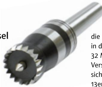
diese Konstruktion, ein drehendes Werkstück anzuhalten, ohne die Maschine abzuschalten, verspricht der Hersteller. Dieser Kranz aus spitzen Zähnen ermöglicht – und das ist die eigentliche Stärke des Stebcenter-Systems – das sichere Einspannen bei exzentrischen Projekten. Lieferbar sind die Mitnehmer mit Morsekonus (MK 2) sowie
