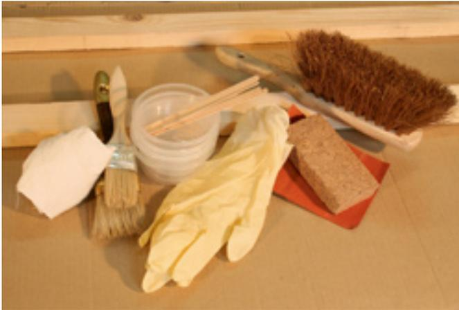
Die Arbeitsutensilien: Verschieden große Pinsel, Mischhilfen, ein Handfeger zum Entstauben und ein Schleifklotz aus Kork samt 180er und 240er Schleifpapier.
