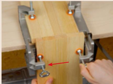
Die Bretter werden zwischen die beiden verschiebbaren Spannanschlüge gelegt und dort mit Schrauben fixiert. Dabei müssen sie links anliegen.
