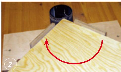
Das eingelegte Brett wird mit der Ecke durch die Schleifrolle gedreht, bis der zweite Anschlag erreicht ist.
