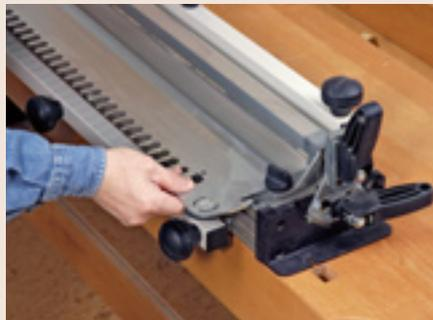
*Schablonenwechsel in Sekundenschnelle: Einfach die äußeren Schrauben lösen, neue Schablone aufschieben und Schrauben wieder anziehen.*
