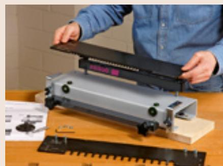
*Eine einfache, aber wirkungsvolle Methode: Die markierten Schablonen werden mit vier Maschinenschrauben an den Metallwinkeln befestigt.*
