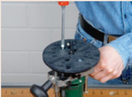
Die mitgelieferte Grundplatte passt auf nahezu jede Oberfräse und wird mithilfe eines Zentrierdorns genau zentrisch zur Fräserachse ausgerichtet.
