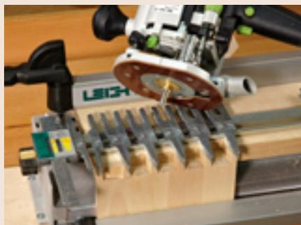
*Die Zinken entscheiden über die Passgenauigkeit der Verbindung. Dazu wird der Kamm vor oder zurück geschoben. Eine Skala erleichtert das Einstellen.*
