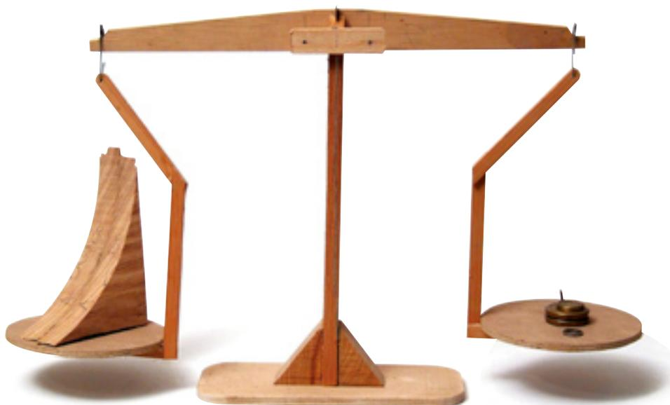
*Mit einer selbst gebauten, leichtgängigen Balkenwaage und einem Satz Gewichte lassen sich die Massen Ihrer Holzproben ermitteln.*
