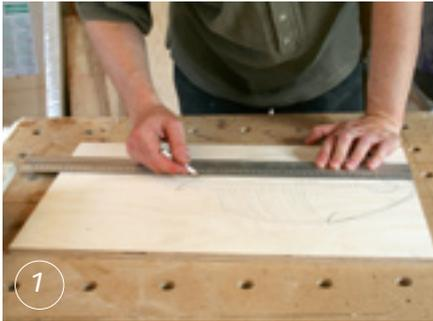
1 Entlang der Mittelachse bauen Sie den Entwurf des Gürteltieres auf. Mit dem Stechzirkel werden die Abstände der Schlitz- und Bögen angerissen. Parallel zur Mittelachse wird die Position der Bohrungen für die Endpunkte der Schlitz- eingezeichnet.
