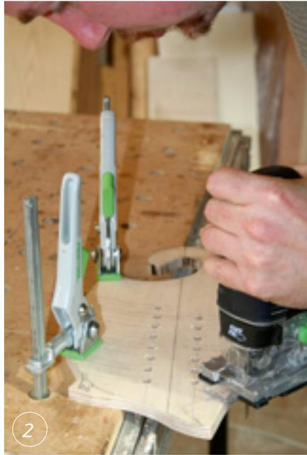
2 Saubere Rundungen am Ende der Schlitz- eine einfache Übung, wenn diese mit dem passenden Bohrer vor dem Sägen gebohrt werden. Die Kontur wird vor den Schlitz- ausgesägt.
