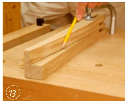
8 Zeichnen Sie die Lichtmaßabstände zwischen den Zapfenbrüstungen anhand der Werkzeichnung an den Zargen an. Legen Sie die Rohlinge auf die Zeichnung, zeichnen Sie die Zapfenlängen an und reißen danach die Zapfendicke mit dem Streichmaß an.
