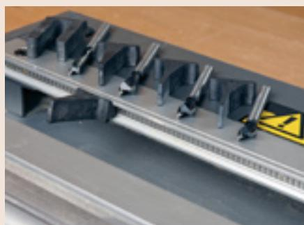
*Einfach Finger für Schwalben einklicken, Position mit dem Bleistift markieren, Schwalben fräsen und später an den gleichen Stellen die Zinkenfinger einklicken.*
