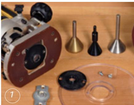
Alle Frässhablonen werden mit Hilfe einer Kopierhülse abgefahren. Wichtig ist nicht nur, die richtige Hülsegröße passend zur Schablone zu benutzen, sondern vor allen Dingen die Kopierhülse genau zur Spindel- bzw. Fräsermitte zu zentrieren. Diese knifflige Aufgabe übernehmen Zentrierkegel oder -stifte (Bild 1). Bei festen, nicht veränderbaren Schablonen beziehungsweise Zinkenabständen sollte sich die Werkstückbreite genau nach der
