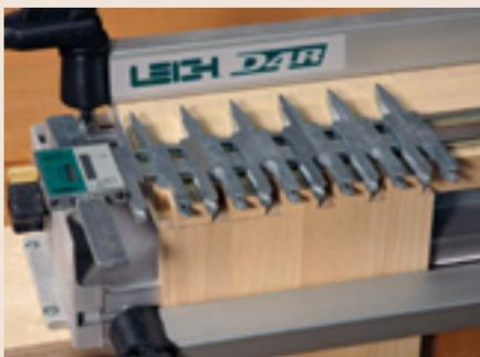
*Das einzige Gerät im Test, das eine völlig freie Zinkeneinteilung ermöglicht. Führungsfinger lösen und auf der Schiene passend verschieben.*
