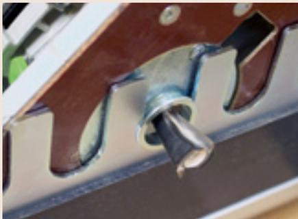
*Die speziell geformte Kopierhülse verhindert, dass die Fräse ungewollt aus der Schablone heraus gehoben wird und dabei den Fräskamm beschädigt.*
