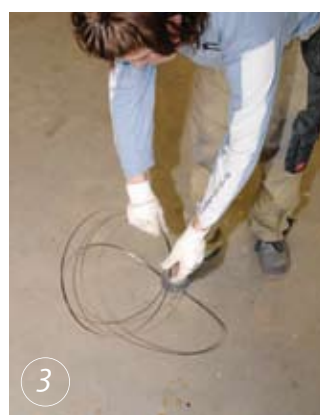
Mit dem richtigen Dreh lassen sich sperrige Bandsägeblätter so dritteln, dass sie sich bequem verstauen lassen.
