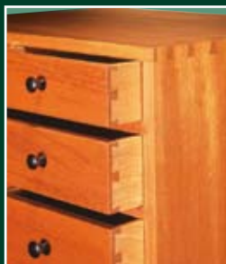
Schwalbenschwanzzinken für halbverdeckte und eckige offene Gratverbindungen
