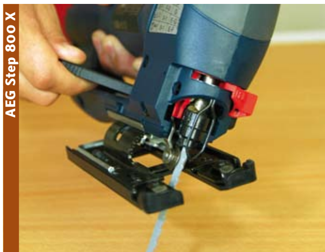
Wie beim AEG -Modell lässt sich der Sägeschuh stets in der Neigung verstellen. Entweder wie hier per Hebel oder mittels Schrauben.
