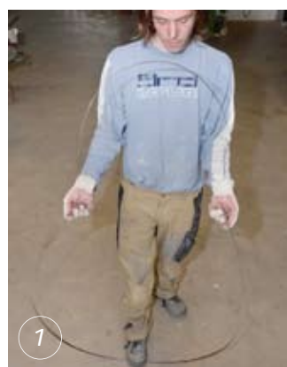
Mit dem richtigen Dreh lassen sich sperrige Bandsägeblätter so dritteln, dass sie sich bequem verstauen lassen.
