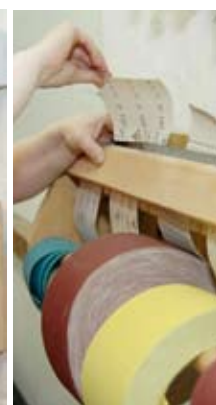
Die scharfe Abrisskante aus Stahl erleichtert das Abtrennen von Schleifleinen oder -papier.
