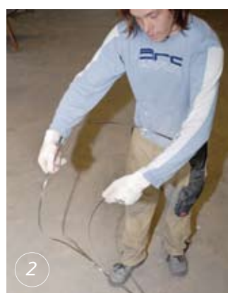
Mit dem richtigen Dreh lassen sich sperrige Bandsägeblätter so dritteln, dass sie sich bequem verstauen lassen.
