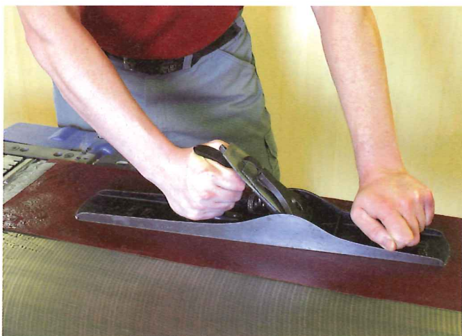
Die Hobelsohle wird auf absolut planer Unterlage mit Schleif-leinen abgerichtet.
