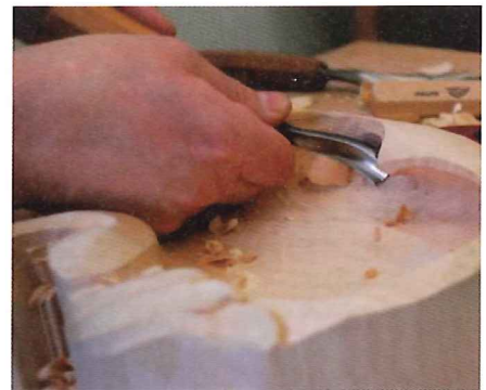
⑧ An der kniffligsten Stelle, der Unterschneidung, ist die Stunde für ein kurzgekröpftes Eisen gekommen.
