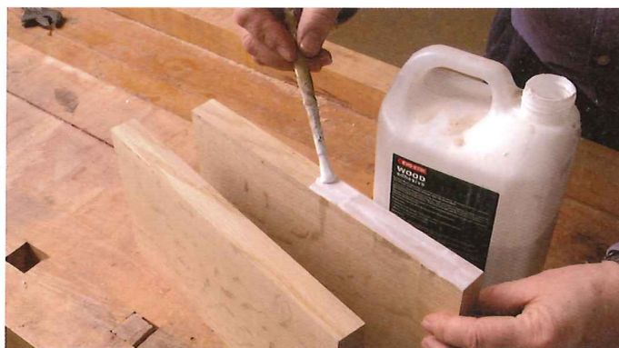
10 Die gefügte Sitzfläche aus massiver Eiche wird verleimt, anschließend geputzt und vor dem Verschrauben unten gewachst.
