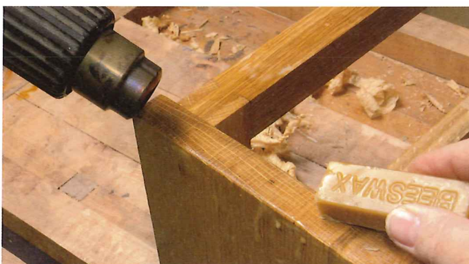
11 Mit einem Heißluftfön findet das Wachs leichter in die Poren.
