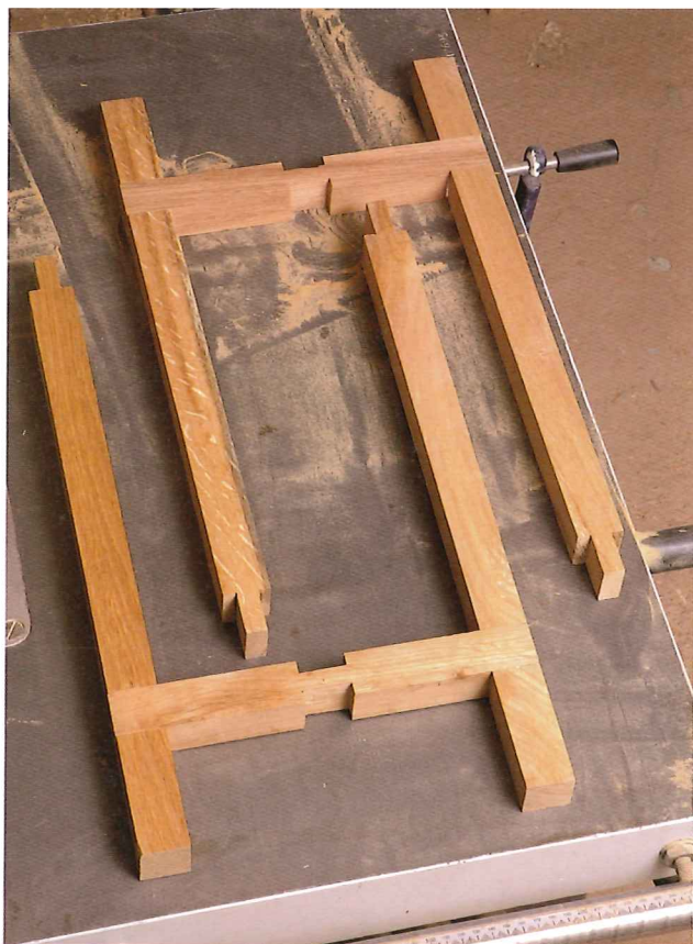
9 Zweimal H: So sieht der Zwischenschritt der Gestell-Verleimung aus.
