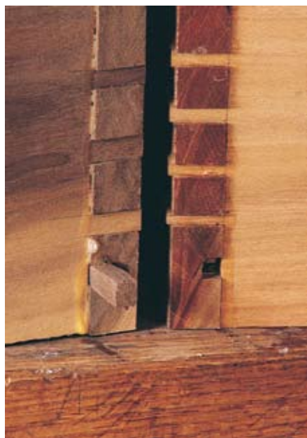
Quadratische Stopfen aus dem passenden Holz verschließen die durchgehobelten Nuten.
