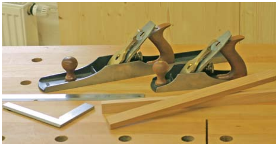
Raubank, Putzhobel, Peilstäbe, Winkel und Lineal lehren Holz den rechten Winkel.
