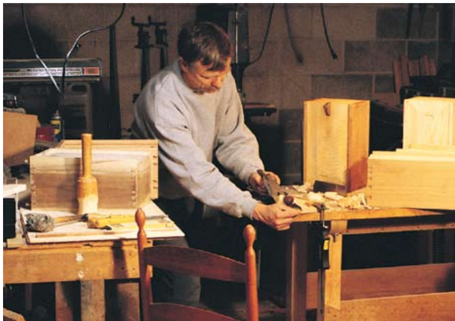
Die Abplattungen an den Deckeln hobelt Kerry Pierce wie einst die Shaker von Hand an.
