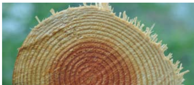
Die vom Stammkern abgewandte Seite eines Brettes wird die linke Seite genannt, sie kann hohl werden.
