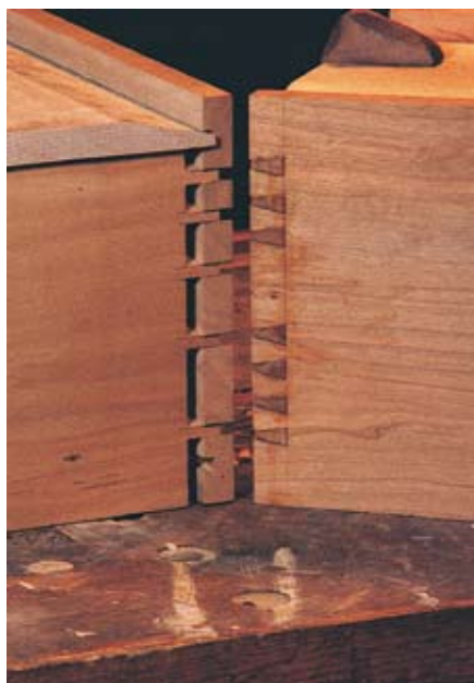
Die Verbindung rechts ist schon geleimt, die linke nur halb zusammengesteckt. Bei der Probe sollten Neu-Holzwerker vorsichtig zu Werke gehen: Schnell reißt das Holz bei zu strammen Verbindungen ein. Wirklich gute Zinken und Schwalben fügen sich ohne großen Druck ineinander.
