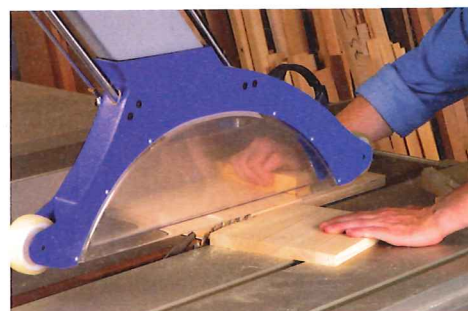
3 Benutzen Sie – trotz der Sperrholzabdeckung – beim Sägen auf jeden Fall die Sägeblatthaube.
