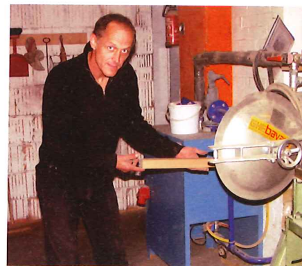
Bugholz wird in der Dämpfmaschine vorbereitet.
