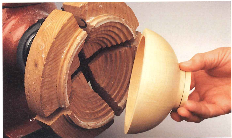
Wiedereinspannen der Schale in die Holzklemmbacken des Spannfutters, um die Unterseite fertig zu drehen.
