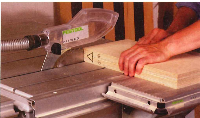
3 Die Rechtwinkligkeit des Schiebeschlittens testen Sie, indem Sie zwei gleich große, aufeinander gelegte Holzplatten absägen.
