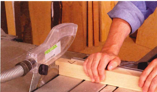
1 Legen Sie zwei markierte Holzleisten zusammen und sägen Sie von den Enden ca. 10 mm ab.
