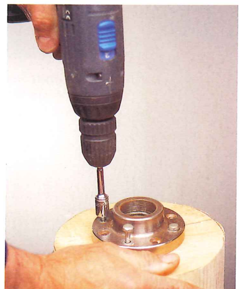
Der Rohling wird auf die Planscheibe gespannt.
