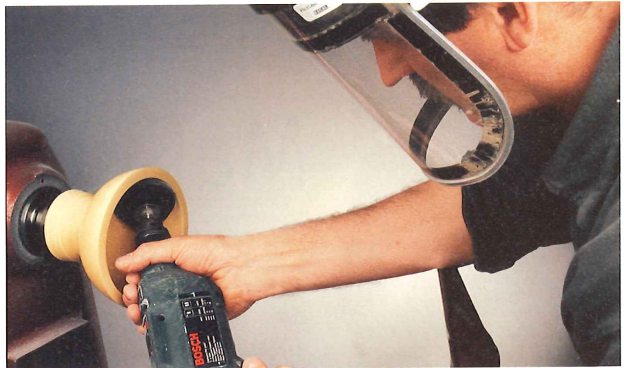
Maschinelles Schleifen ist für eine Schale dieser Art eine geeignete Technik. Schleifen Sie zuerst das Schaleninnere.
