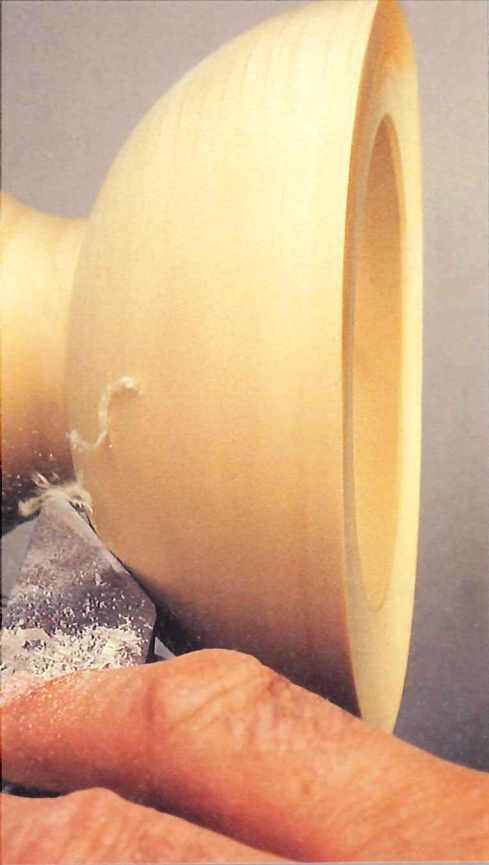
Maschinelles Schleifen ist für eine Schale dieser Art eine geeignete Technik. Schleifen Sie zuerst das Schaleninnere.
