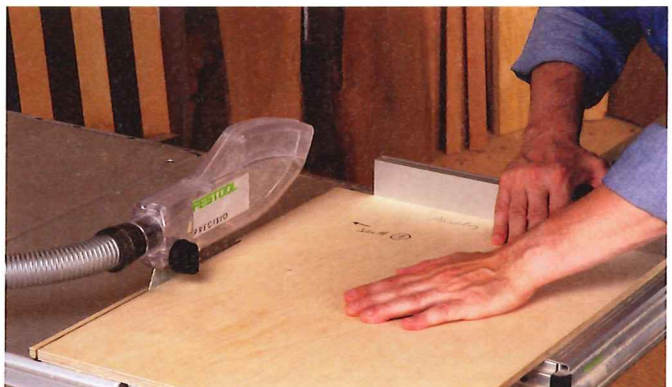
4 Sägen Sie einen 5 bis 10 mm schmalen Streifen von einer Längskante ab und wiederholen Sie den Vorgang mit der gegenüberliegenden Kante (Platte umdrehen).
