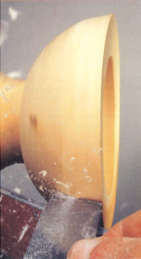
Wiedereinspannen der Schale in die Holzklemmbacken des Spannfutters, um die Unterseite fertig zu drehen.
