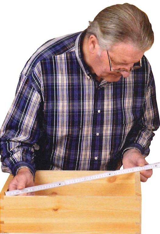
Ein unverzichtbares Messwerkzeug mit teilweise erheblichen Qualitätsunterschieden: der Zollstock, Meter- oder Gliedermaßstab
