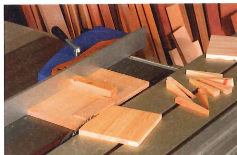
2 Führen Sie die Schablone mit eingeklinktem Brett exakt zwischen Anschlag und Kreissäge in Richtung Keilspitze.
