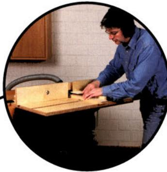
Mit ein paar Brettern und Scharnieren, können Sie bei Bedarf auch den mobilen Frästisch aus meinem "Handbuch Oberfräse" im Nu an der Tischzarge der Multiwerkbank befestigen. Wenn Sie den Fräsanschlag entfernen, nutzen Sie den Frästisch einfach als Werkstückverlängerung.
