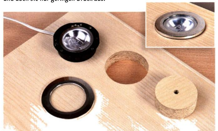
Dadurch erhalten Sie auf beiden Seiten absolut saubere Schnittkanten, die Sie nur noch minimal mit Schleifpapier etwas "brechen" müssen.
