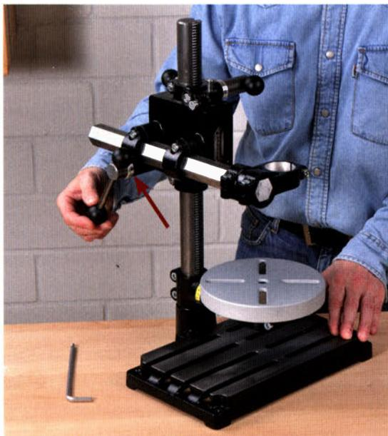
Mit dem Auslegerhebel können Sie den Sechskant-Arm vor und zurück bewegen, über eine kleine Skala am Hebel (Pfeil) können Sie den Verschiebeweg millimetergenau ablesen.
