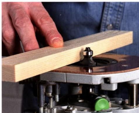
Parallelanschlag, Kopier- hülse oder Führungsschie- ne samt Adapter an die Oberfräse montiert werden. Deshalb eignen sich diese sogenannten Kantenfräser hervorragend für den Ein- steiger, der seine ersten Fräsversuche unternimmt.
