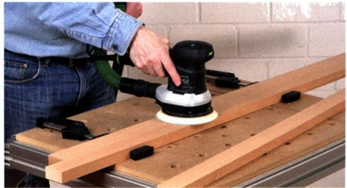
**Schmale Teile zusammenlegen** – damit wird die Auflagefläche des Schleiftellers vergrößert und die Maschine kann nicht so leicht wegkippen. Achten Sie darauf, dass der Schleifteller immer vollflächig auf dem Werkstück aufliegt.
