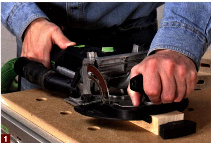
Stellen Sie die Maschine auf die halbe Sprossenstärke ein und fräsen Sie mithilfe des Leistenanslags je einen Dominodübel in die Stirnkanten der Sprossen.
