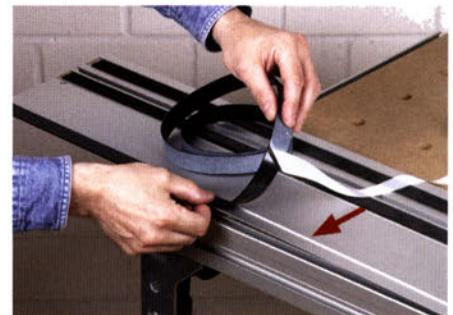
Ziehen Sie nach und nach die Schutzfolie von dem neuen Splitterschutz ab und kleben Sie ihn sorgfältig genau entlang der Führungskante (Pfeil) auf die Schiene.
