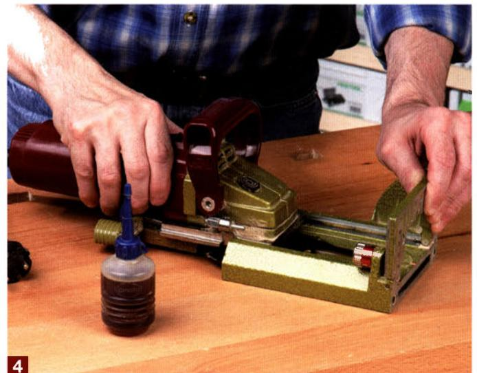
**4** Beim Einschieben darauf achten, dass der Fräser nicht gegen den Anschlag stößt und dabei die Schneiden beschädigt werden.
