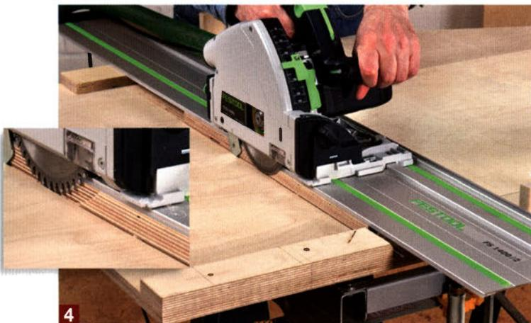
4 Mit dem ersten Sägeschnitt sorgen Sie dafür, dass diese Kante genau rechtwinklig zu den Längskanten verläuft. Sägen Sie dazu so wenig wie möglich ab.
