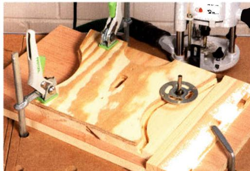
Ein 10-mm-Nutfräser mit eingelöteter Hartmetallspitze und extrem langem Schaft ist ideal zum Herausfräsen von Konturen nach einer Schablone mithilfe einer 17-mm-Kopierhülse.
