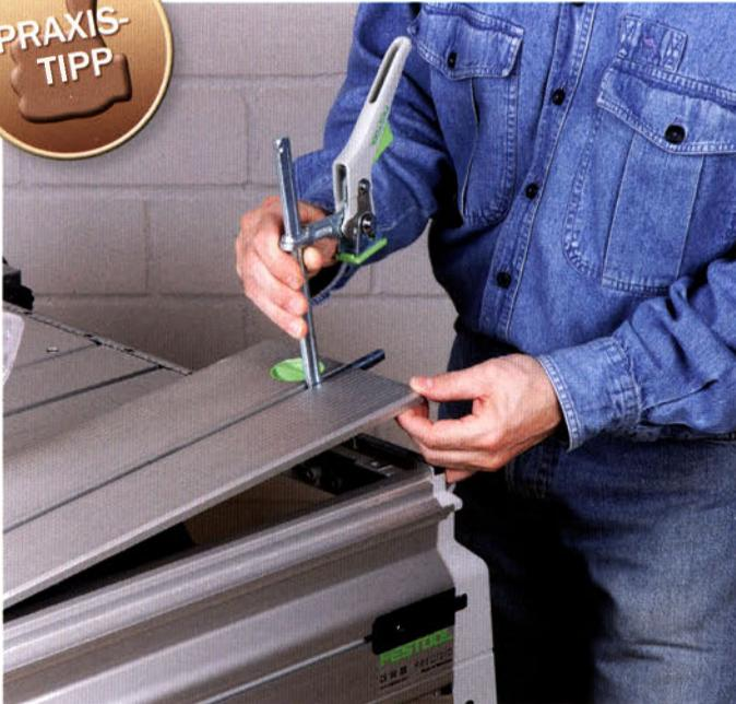
Eine Hebelzwinde, die einfach in die Nut der Tischeinlage eingeschoben wird, bringt noch mehr Sicherheit und Genauigkeit beim Zuschnitt. Benutzen Sie wann immer es geht Hebelzwingen, da die sich bei Vibrationen der Maschine nicht lösen können.
