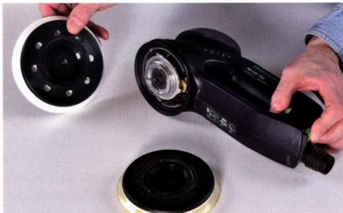
Bei diesem Modell lässt sich der Schleifteller ganz ohne Werkzeug wechseln. Die Maschine muss dazu auf Grobschliff eingestellt sein, dann wird der grüne Knopf neben dem Absaugstutzen gedrückt (Spindelretrierung) und der Teller einfach abgedreht.
