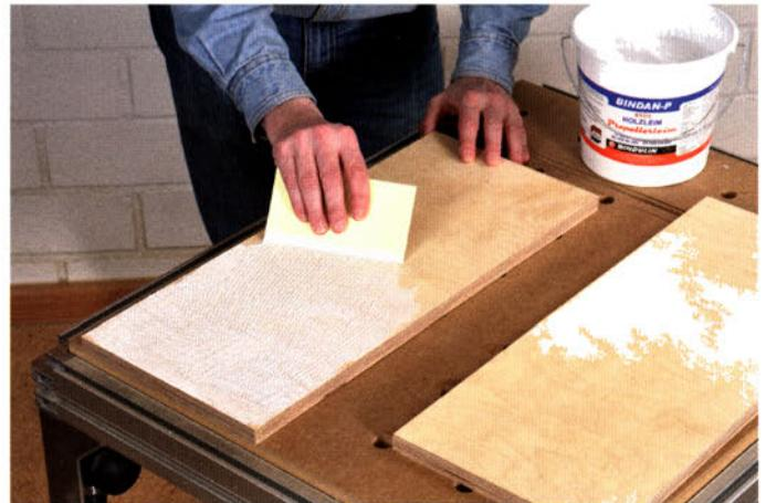
Bei großen Flächen verteilt man den Leim am besten gleichmäßig mit einem Zahnpachtel. Am einfachsten klappt das mit Leim direkt aus einer Dose oder einem Eimer.
