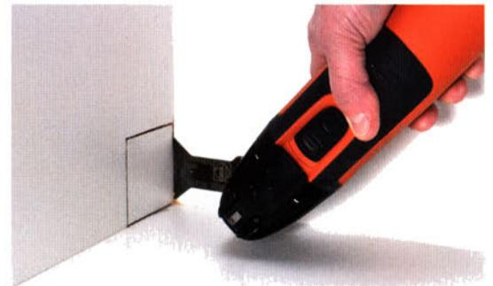
Mit dem robusten HSS-Segmentsägeblatt entfernen Sie z. B. mühelos harten Kitt aus alten Fenstern und mit der dreieckigen Hartmetall Raspel sind selbst millimeterdicke Lackschichten im Handumdrehen verschwunden.
