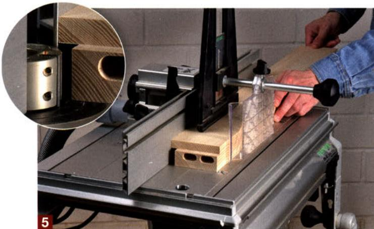
**5** Sind alle Dominolöcher gefräst, wird in mehreren „Fräsgängen“ ein 30 mm hoher und 12 mm tiefer Falz in die Rahmenteile gefräst.
