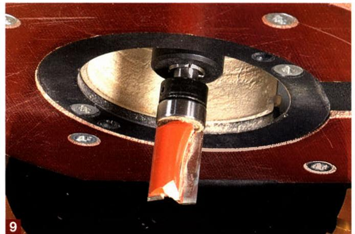
Bei diesem Bündigfräser ( $\varnothing$  12,7 x 19 mm Schneidenlänge) befindet sich das Kugellager am Schaft. Dadurch kann er problemlos ins Holz eintauchen.
