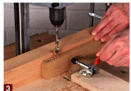
Ein Schubstangenspanner erzeugt einen horizontalen Druckpunkt. Mit einer einfachen Sechskantschraube mit Mutter am Ende der Schubstange lässt sich die Druckstärke genau anpassen.
