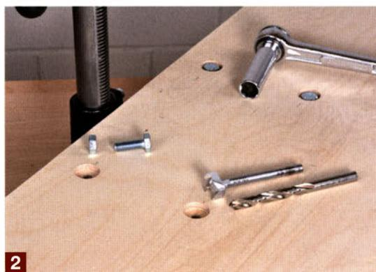
Zeichnen Sie sich auf eine 21 mm dicke Multiplexplatte den Abstand der beiden äußeren T-Nuten an und bohren Sie zuerst mit einem Forstnerbohrer ( $\varnothing$  mindestens wie Steckschlüssel) ein Sackloch, das Sie anschließend mit einem 10er Bohrer durchbohren.
