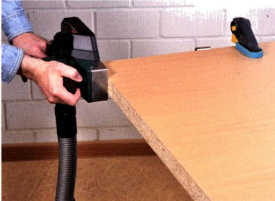
Lassen Sie die Finger vom Elektrohobel, wenn Sie eine Tür kürzen wollen. Es sei denn Sie mögen jede Menge Späne, schief gehobelte Kanten und ausgerissene Türenden. Ganz abgesehen davon, dass Sie nach dem Laminatverlegen mindestens 10 mm abhobeln müssten.
