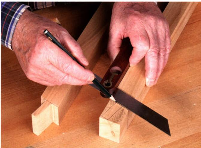
Immer dann wenn ein anderer Winkel als  $90^\circ$  oder  $45^\circ$  verlangt wird, ist die Schmiege genau das richtige Messinstrument.
