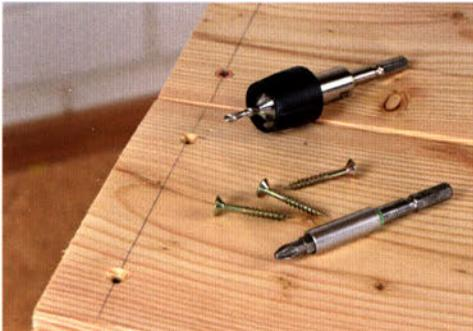
Mit einem Bohrsenker können Sie in einem Arbeitsgang das Führungsloch für das Schraubengewinde herstellen und den Schraubenkopf versenken. Verfügt er zusätzlich noch über einen Tiefenstopp, sind alle Senkungen gleich tief. Bei hochwertigen Modellen ist der Tiefenstopp drehbar gelagert, sodass er keine Spuren auf dem Werkstück hinterlässt. Zudem lassen sich die Senk- und die Führungslochtiefe stufenlos einstellen.
