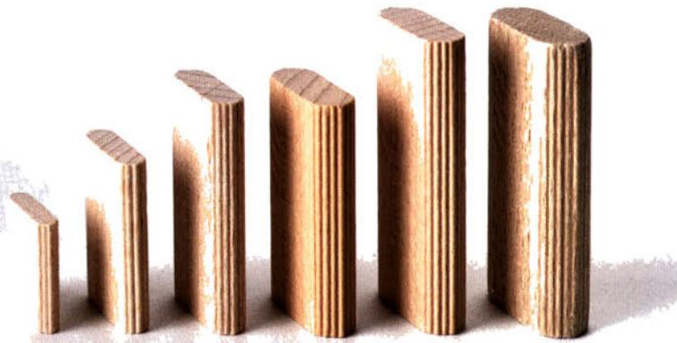
Mit der Dominofräse und den passenden Dominodübeln in den Größen 4 x 20, 5 x 30, 6 x 40, 8 x 40, 8 x 50 und 10 x 50 mm (von links nach rechts) können Sie nicht nur großformatige Platten (ab ca. 9 mm Holzstärke), sondern auch kleinste Leisten verdrehsicher und extrem fest miteinander verbinden.
