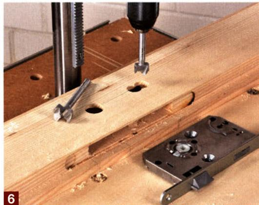
Stecken Sie den Stulp in die Aussparung und überprüfen Sie, ob er auch komplett versenkt eingelassen wurde – sonst etwas nachfräsen. Das Loch für den Türdrücker bohren Sie mit einem 25-mm-Forstnerbohrer. Für das Schlüsselloch einen 20-mm-Bohrer einsetzen.
