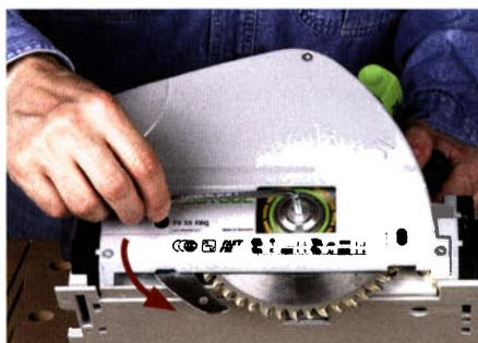
Drehen Sie den Sechskantschlüssel in Pfeilrichtung um die Befestigungsschraube zu lösen. (Merkhilfe: „So wie ich lauf, so geh ich auf.“).
