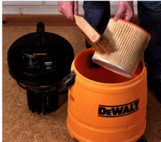
Ohne Staubsack ist der Faltenfilter im Nu mit Staub verstopft und muss aufwändig von Hand gereinigt werden, weil die Saugleistung drastisch nachlässt. Ein neuer Filter kann je nach Qualität schnell 50 bis 100 Euro ausmachen. Bei regelmäßigem Einsatz eines Staubsacks hält ein Faltenfilter jedoch viele Jahre.
