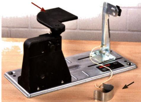
Mit diesem Untergestell können Sie den Hobel auch stationär über Kopf betreiben. Vorschrift ist die Benutzung einer schwenkbaren Messerschutz-einrichtung (roter Pfeil), einer Halteklammer (schwarzer Pfeil) zur Arretierung des Ein-/Aus-Schalters und eines externen Sicherheitsschalters.
