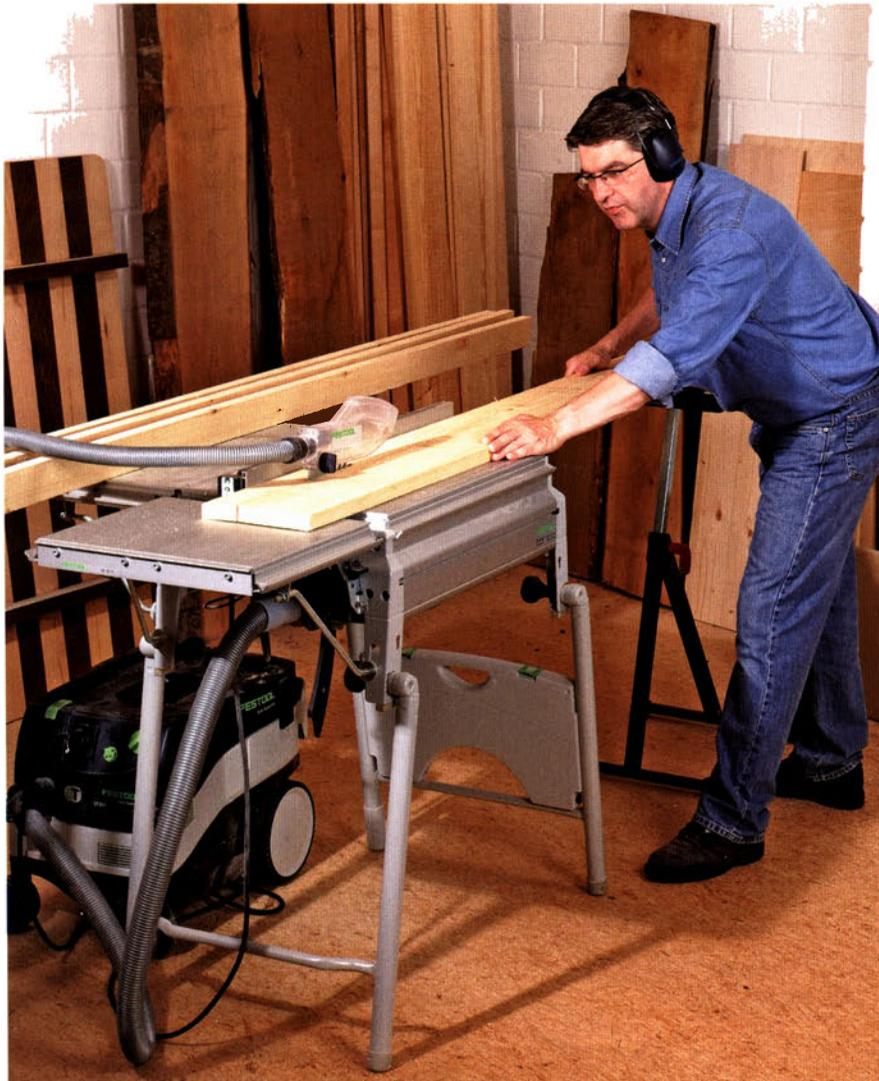
Sägen dann zu „halbstationären“ Tischkreissägen erweitern können. Halbstationär deswegen, weil sie auch dann noch so flexibel bleiben, dass man sie problemlos transportieren kann. Man darf bei aller Mobilität dieser Sägen nur eines nicht vergessen: Wird die Säge transportiert, kann es unter Umständen nötig sein, die Rechtwinkligkeit der Anschläge zu überprüfen und gegebenenfalls neu zu justieren.
