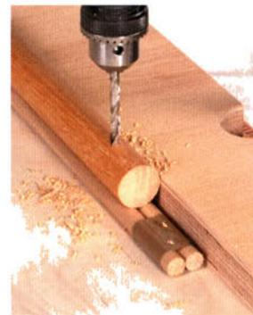
Als Alternative können Sie auch einfach zwei Dübelstäbe mit Klebeband verbinden und als Unterlage benutzen.
