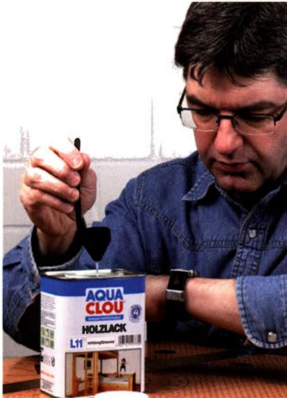
Die Viskosität (Fließgeschwindigkeit) des Lacks mit Messbecher kontrollieren. Dazu wird er bis über den Rand in die Farbe eingetaucht und anschließend wieder heraus gezogen. Dann wird die Zeit in Sekunden gemessen, bis der Flüssigkeitsfaden beim Auslaufen abreißt.
