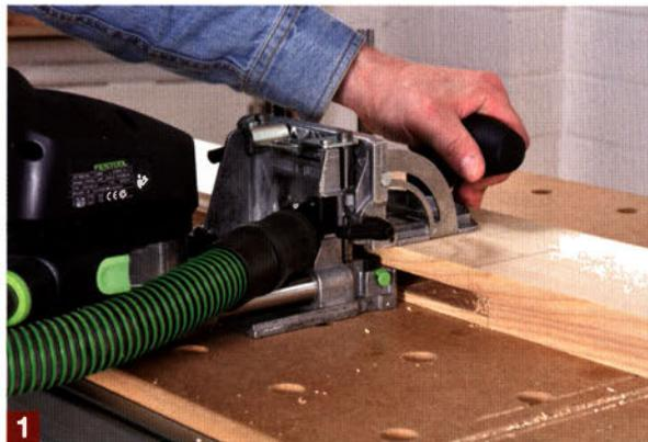
Versetzen Sie den Anschlag in der Höhe um 2 mm und erweitern Sie die Schlitzbreite mit dem 14-mm-Fräser auf 16 mm. Die Frästiefe ist auf die maximale Tiefe von 70 mm eingestellt.
