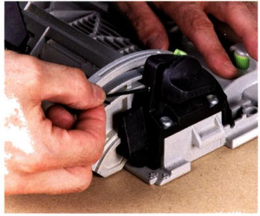
Der maximale Neigungswinkel des Sägeblatts bei dieser Tauchsäge beträgt 45°. Diese Schräge wird sehr häufig benutzt, wenn man Schränke oder Kisten auf Gehrung zusammenfügen möchte. Damit man nicht jedesmal einen Testschnitt vornehmen muss, lässt sich die Neigung durch eine kleine Einstellschraube genau begrenzen.
