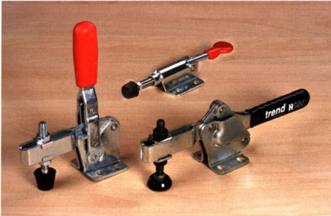
Vertikale (li.) und horizontale (re.) Schnellspanner sind die wichtigsten Spannformen und sollten in keiner Holzwerkstatt fehlen. Der spezielle Schubstangenspanner (mi.) mit horizontalem Druckpunkt, ist ideal bei schmalen Werkstücken oder bei Druck gegen eine schmale Kante.
