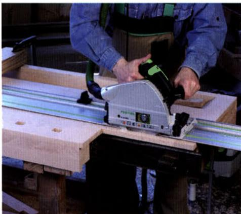
Eine genau rechtwinklige Ausklung in eine Hobelbankfläche zu sägen gelingt am besten mit einer Tauchsäge samt Führungsschiene. Dabei kann man nicht nur mitten ins Werkstück eintauchen, sondern auch die Schnitttiefe millimetergenau voreinstellen.
