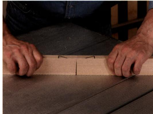
Legen Sie die beiden Holzleisten hochkant zusammen und sägen Sie von den Enden mit Hilfe des Schiebeschlittens oder Queranschlags ca. 10 mm ab. Wenn Sie die Schnittflächen aneinanderstoßen, zeigt ein Spalt, ob das Sägeblatt nachjustiert werden muss oder nicht.
