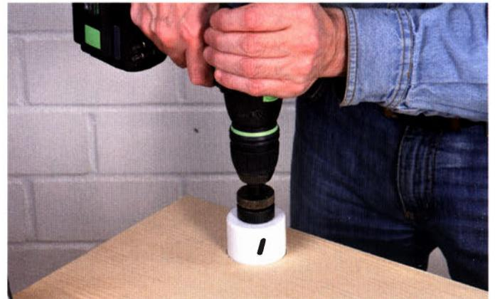
Betreiben Sie die Maschine bei einer Lochsägengröße von 54 mm im ersten Gang mit maximal 250 U/min. Halten Sie die Maschine mit beiden Händen fest und üben Sie nur geringen Druck aus.
