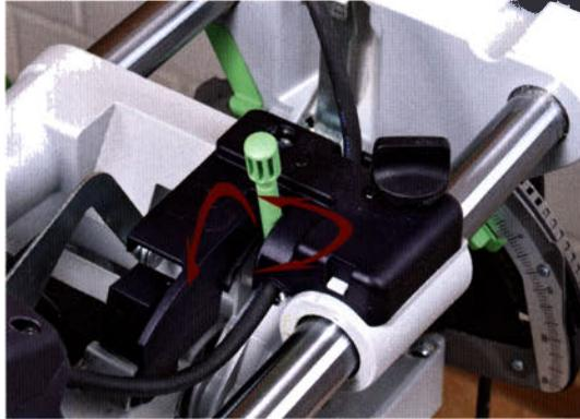
Ein grüner Hebel, der sich hinter dem Sägeaggregat befindet, kann zur Begrenzung der Kapp- bzw. Sägetiefe einfach nach vorne geklappt werden. Ist er in dieser Position eingerastet, lässt sich die Schnitttiefe über den gleichen Hebel stufenlos und sehr präzise einstellen, indem man ihn einfach nach links oder rechts dreht. Damit können im Handumdrehen bis zu ca. 250 mm lange Nuten, Falze und Abplattungen gesägt werden.
