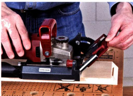
Achten Sie darauf, dass sich der Flachdübelschlitz immer im oberen Drittel der Gehrungskante befindet und nicht genau in der Mitte. Denn je nach Brettstärke und Flachdübelgröße fräsen Sie den Schlitz sonst möglicherweise auf der Außenseite durch (s. Bild links roter Kreis). Aus diesem Grund liegt vielen Flachdübelfräsen eine 4 mm dicke Aufsteckplatte aus Kunststoff bei. Die wird einfach auf den Schwenkansschlag geschoben und versetzt dann den Schlitz weiter nach oben (s. Bild rechts).
