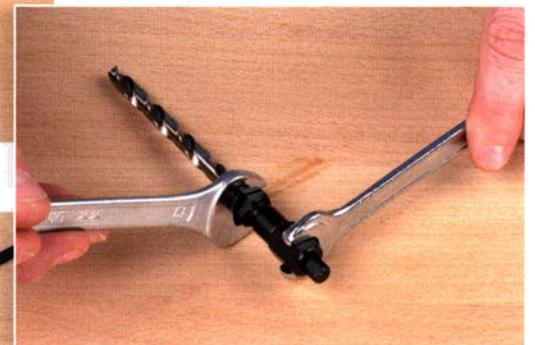
Das gleiche gilt auch für die Aufstecksenker mit Snappy-Schaft. Mit einem Inbusschlüssel sind stumpfe Bohrer im Nu durch handelsübliche Metall- oder Holzbohrer ersetzt.
