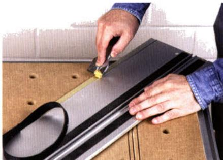
Ziehen Sie den alten Splitterschutz einfach mit der Hand ab und entfernen Sie die groben Klebereste am besten mit einem Ceranfeld-Schaber.
