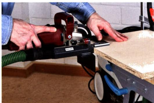
Bei den heutigen Modellen wird ein solcher Stützwinkel – natürlich werkzeuglos – auf den Gehäuseboden geschoben und arretiert. Dann wird die Maschine bei beiden Fräsungen (hochkant s. Bild links und flach s. Bild oben) über den nach unten geklappten Schwenkschlag an den Platten positioniert.
