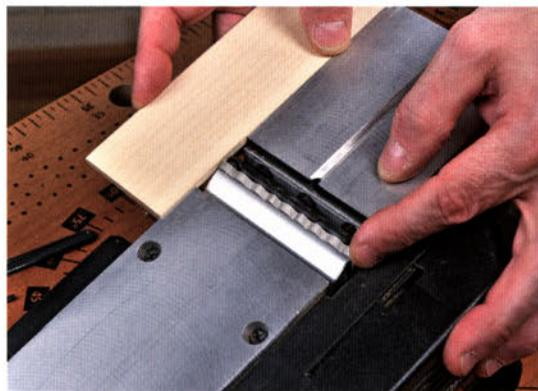
Zum Schluss die seitliche Position der Messer zur Hobelsohle ausrichten. Wenn die Messer in der richtigen Höhe eingestellt wurden, können Sie in der Spanabnahmenstellung „0“ ein perfektes wellenförmiges Profil in die Fläche hobeln. Authentischer wirkt das Ganze, wenn Sie die Maschine dabei etwas in weitläufigen Schwenks hin und her bewegen.
