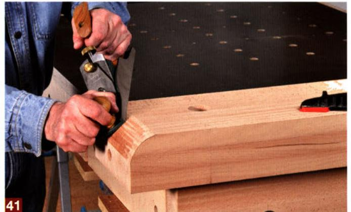
41 Die Spannbackenenden werden zunächst von Hand mit einem Hobel gerundet und anschließend mit einem Exzenterschleifer nochmals fein geschliffen.
