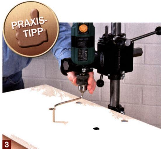
Sollte das nicht der Fall sein, unterfüttern Sie die Multiplexplatte an dieser Stelle mit einem oder mehreren Furnierstreifen und testen dann nochmals mit dem Metallstab den rundum gleichen Abstand zur Multiplexplatte.
