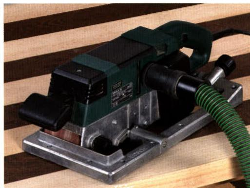
Mit dem hinteren Drehknopf können Sie die Maschine samt Schleiffläche mehr oder weniger weit aus dem Schleifrahmen vorstehen lassen. Damit lässt sich die Abtragsleistung des Bandschleifers sehr präzise einstellen.
