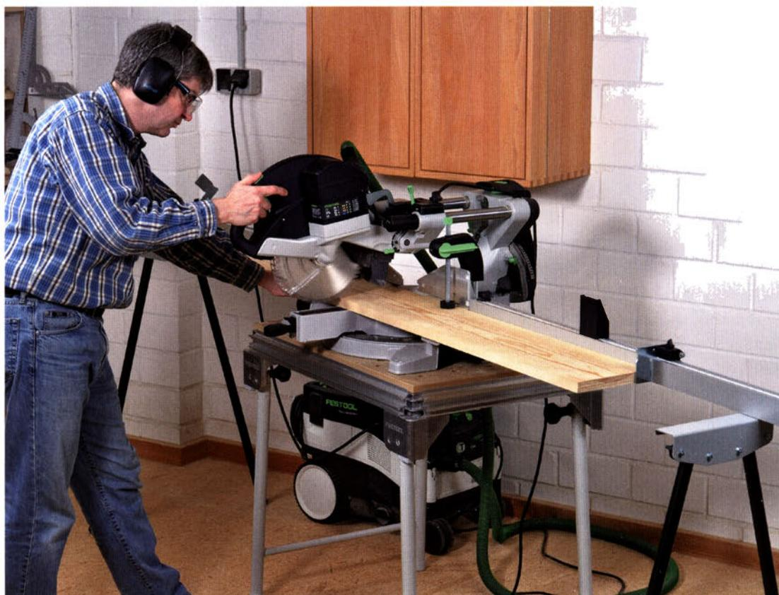
gen von bis zu 305 mm bei einer Werkstückdicke von sensationellen 88 mm (bei lediglich 260 mm Sägeblattdurchmesser!).
