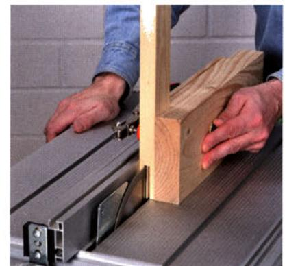
Fixieren Sie das Werkstück mit dem Schnellspanner (Kniehebelspanner) im Falz der Vorrichtung. Schieben Sie dann den Klotz am Längsanschlag vorbei über das laufende Sägeblatt. Auch hier wird das Werkstück wieder gedreht und ein weiteres Mal vorbeigeschoben.
