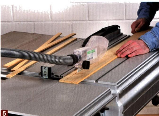
5 Aus einem mit der Dickenhobelmaschine auf 6 mm Stärke gehobelten Brett sägen Sie anschließend auf der Kreissäge 19 mm breite Streifen. Die Kanten dieser Holzstreifen werden dann auf einem Frästisch mit einem ...
