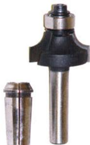
die gesamte Länge der Spannzanze ausfüllt (mindestens  $\frac{3}{4}$  der Schaftlänge). Nur dann ist ein vibrationsfreier, exakter Rundlauf des Fräasers garantiert, ohne die Spannzanze zu beschädigen. Im schlimmsten Fall, kann sich sogar der Fräser lösen.
