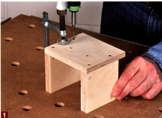
Zuerst schrauben Sie die Frontplatte (2) mit den beiden Winkelplatten (3) zusammen. Vergessen Sie nicht die Löcher unbedingt vorzubohren und zu versenken.
