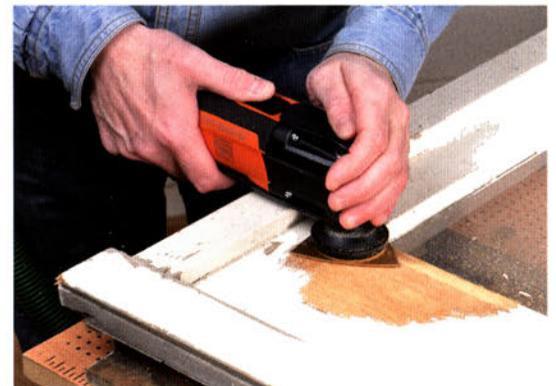
z. B. fest eingebaute Türfutter kürzen beim Laminatverlegen, verwitterte Fenster und Türen abschleifen, beschädigte Fliesen heraustrennen und austauschen, Kabel- und Schlauchdurchbrüche in enge Schränke sägen, Klebstoffreste von Treppen- und Bodenbelägen abschaben, defekte Silikonfugen entfernen und sogar Klingen und Schneiden von Gartengeräten nachschärfen. Es gibt ganz sicher kein anderes Elektrowerkzeug, das Sie häufiger im Haushalt einsetzen können, als ein oszillierendes Multiwerkzeug.
