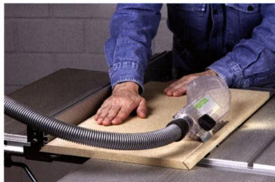
Bei Schrägschnitten stellen Sie den Längsanschlag ca. 2 – 3 mm breiter ein, als das tatsächliche Breitenmaß. Schrägen Sie dann zunächst nur eine Kante ab. Diese Maßzugabe ist deshalb so wichtig, weil sich beim zweiten Schnitt (Bild rechts) die abgeschrägte Kante später mit der Spitze ein klein wenig unter den Längsanschlag schiebt.
