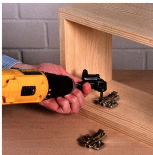
Wer nur um die Ecke schrauben möchte, dem reicht ein einfacher und handlicher Winkelschraubvorsatz (1) völlig aus. Möchten Sie aber auch handelsübliche Bohrer einsetzen, ist ein Winkelbohrkopf mit Bohrfutter die bessere Wahl. Neben starren 90°-Bohrköpfen (2) bietet z. B. die Fa. Milescraft den sogenannten Orbiter an (3). Hier können Sie Bohrfutter, Griff und Maschinenaufnahme in nahezu jeden beliebigen Winkel zueinander verdrehen.
