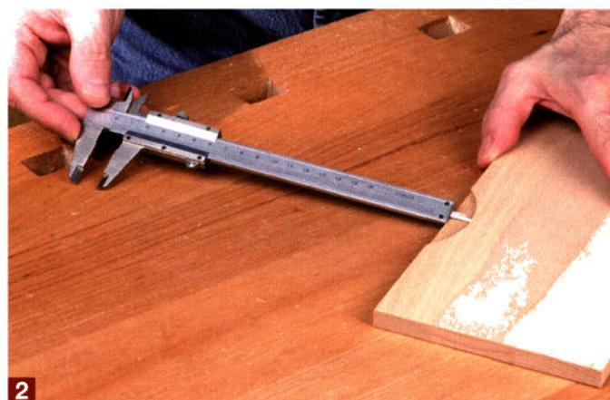
**2** Anschließend messen Sie die Schlitztiefe mit einem Messschieber nach. Die Tiefe sollte genau 13 mm betragen.
