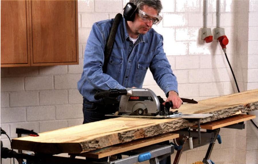
Ein absolutes Muss: Eine zur Handkreissäge passende Führungsschiene, denn damit gelangen auch dem Einsteiger auf Antrieb präzise Holzzuschnitte.
