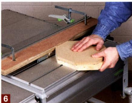
Besonders wichtig ist, dass die Schablone mit seitlichem Druck exakt an der Leiste vorbeigeführt wird, damit keine Ungenauigkeiten an den Kanten des Werkstücks entstehen. Sollte dennoch einmal etwas nicht so präzise sein wie Sie es sich vorstellen, brauchen Sie nur ein weiteres Mal an der Führungsleiste vorbei zu fahren. Solange die Schablone auf dem Werkstück befestigt ist, lässt sich dieser Vorgang beliebig oft wiederholen.
