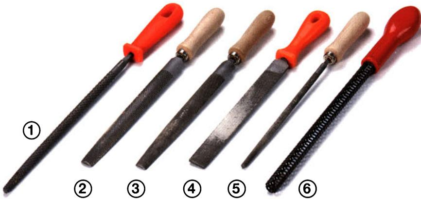
Vor allem bei geschwungenen Bauteilen, wie diesem Tischbein, lässt sich die endgültige Form nur von Hand mit Raspel, Feile und Schleifpapier ausarbeiten. Dabei muss das Werkstück immer gut festgespannt sein und darf nicht federn.
