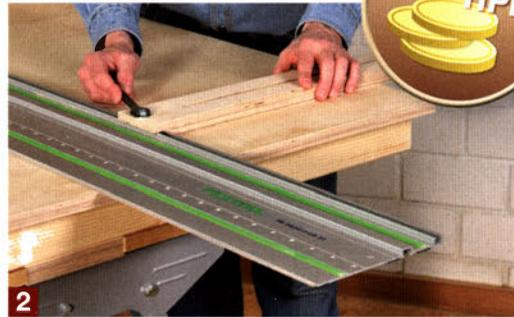
2 Dann die beiden selbstgebauten Parallelschnitthilfen in die obere Führungsnut der Schiene einschieben und dort mit der M8er Schraube fixieren.
