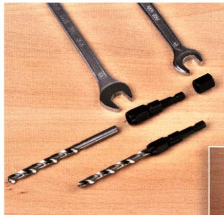
Eine spezielle Schaftaufnahme macht aus einem normalen Metallbohrer einen Snappy-Bohrer. Stumpfe oder beschädigte Bohrer können so auch schnell mal ausgetauscht werden.
