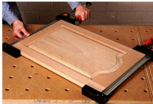
Korpuszwingen haben ebenfalls einen hohen Pressdruck und die speziellen Spannbacken erleichtern das rechtwinklige Spannen.
