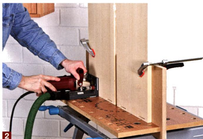
Die Seitenteile hochkant gegen das Brett legen und festspannen. Fräse einmal links und einmal rechts an der Holz-kante anlegen und je einen Schlitz fräsen.
