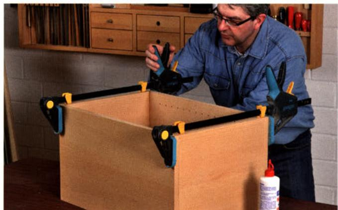
Richtige Position: Die Schiene läuft mittig über Deckel und Bodenkante und die gesamte Spannfläche der Backen ist ausgenutzt.
