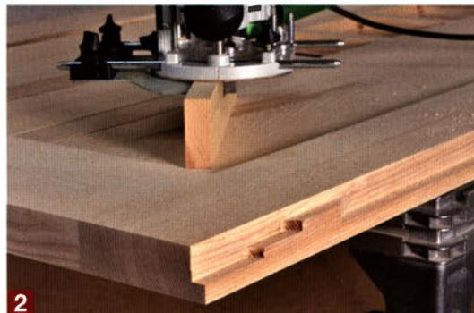
Den restlichen Falz (25 mm hoch und 13 mm tief) fräsen Sie mit der handgeführten Oberfräse samt Parallelanschlag und einem großen Nutfräser in mehreren Etappen heraus.
