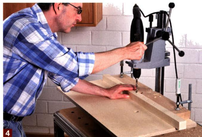
4 Zum Schluss müssen Sie nur noch die Zentrierspitze des Holzbohrers in die Markierungspunkte der Dübelspitzen einstecken und auf dem Bohrständer die senkrechten Löcher in die Pfosten bohren.
