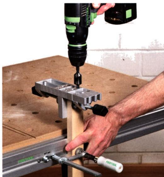
Das präzise Einbohren von Holzdübeln gelingt nur mit speziellen Dübelhilfen. Beim Einsatz dieser Bohrhilfen müssen Sie allerdings ein paar Dinge beachten, damit die Teile später auch perfekt zusammenpassen. Leider stehen diese Tricks in keiner Bedienungsanleitung.
