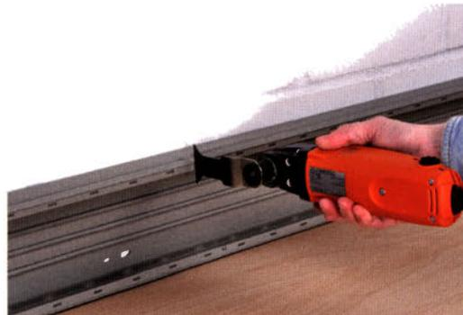
Auch Kunststoffe können Sie mit den Sägeblättern problemlos bearbeiten, wie hier beim Ausklippen eines Kabelkanals. Selbst montierte und mit Kabeln gefüllte Kästen können gesägt werden, ohne die Kabel zu beschädigen.
