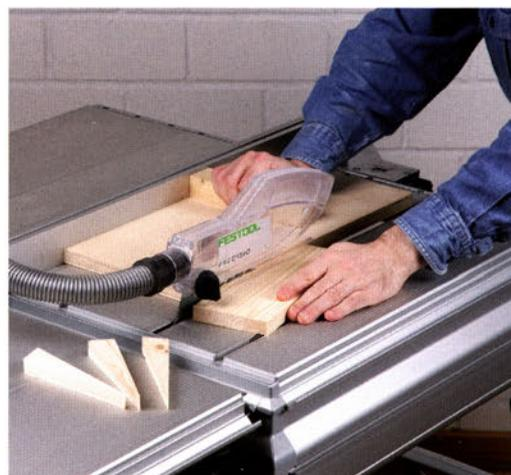
Legen Sie dann das Brett, aus dem Sie die Keile zuschneiden möchten, in die Ausklinkung und schieben Sie es zusammen mit der Vorrichtung am Anschlag vorbei. Der aufgeschraubte Holzklötz erleichtert das Schieben der Schablone.
