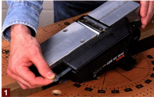
Mit einem kleinen Keil fixieren Sie zuerst die Hobel- bzw. Messerwelle. Danach lösen Sie die drei Schrauben so weit ...
