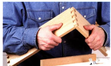
Überprüfen Sie vor dem Verleimen immer die Passgenauigkeit aller Holzverbindungen. Denn nur dicht anliegende Holzteile können vernünftig gepresst werden und ergeben eine hohe Festigkeit. Eine perfekte Verleimung bricht dann immer neben der Leimfuge.
