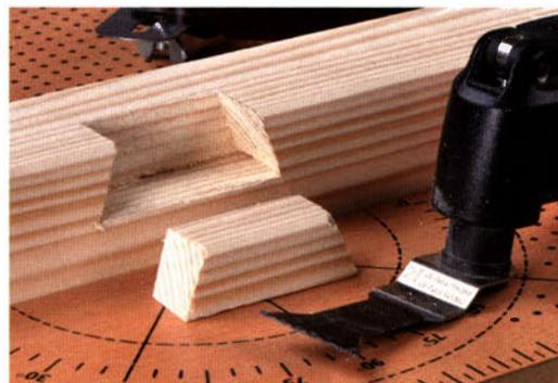
Mit dem E-Cut-Sägeblatt können Sie z. B. in einen Balken eine komplizierte Aussparungen für eine schwalbenschwanzförmige Holzverbindung herstellen, ohne dazu einen Stechbeitel einsetzen zu müssen.
