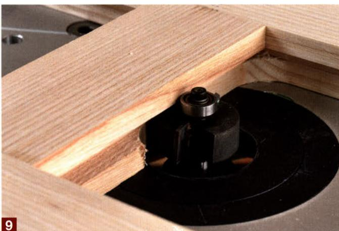
Mit einem Falzfräser (Falztiefe 9,5 mm) mit Kugellager fräsen Sie die untere Nutwange aus den 5 quadratischen Feldern für die Glasfüllungen heraus. Dabei liegt das Kugellager an der oberen Nutwange an. Die noch runden Ecken werden anschließend von Hand mit einem scharfen Stechbeitel eckig ausgestochen, dabei nicht zuviel auf einmal wegstechen!
