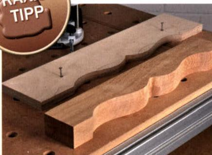
Durch den Einsatz beider Bündigfräser können Sie bis zu 50 mm dicke Hölzer mit einer Schablone kopieren. Wichtig: die Kontur zuerst grob mit der Stichsäge aussägen.
