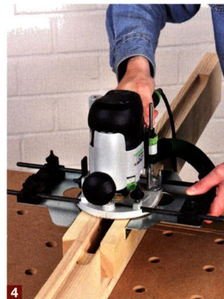
Den 20 mm breiten und etwa 3 mm dicken Stulp fräsen Sie am besten mit einem 20-mm-Nutfräser und doppeltem Parallelanschlag ein. Dabei wird der Rahmen quasi eingeklemmt.
