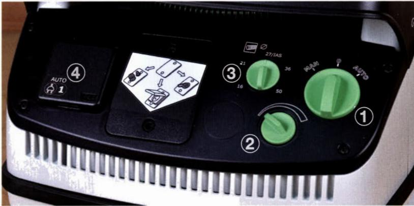
Die meisten Sauger verfügen neben dem Einschaltrehknopf (1) noch zusätzlich über eine stufenlose Saugkraftregulierung (2). Bei sehr hochwertigen Modellen können Sie auch den Schlauchdurchmesser (3) einstellen, damit die Luftgeschwindigkeit korrekt gemessen wird. Eine zusätzliche Steckdose (4) mit Einschaltautomatik sollte keinesfalls fehlen, dann wird der Sauger automatisch über das dort angeschlossene Elektrowerkzeug ein- und wieder ausgeschaltet.
