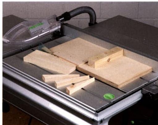
Stellen Sie den Parallelanschlag der Kreissäge genau auf die Breite der Schablone ein. Benutzen Sie unbedingt die Sägeblatt-höhe Ihrer Tischkreissäge, sie wurde hier ausschließlich für das Foto entfernt!
