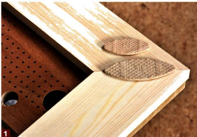
Wenn es die Länge der Gehrungsfuge zulässt, sollten Sie immer den größten Flachdübel auswählen. Der Typ S6 (unten) ist nochmal um einiges größer als der normale 20er Flachdübel.
