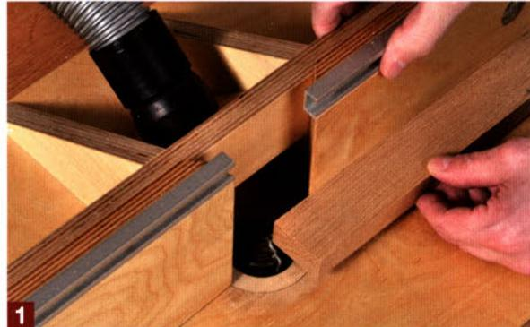
Die Anschlagbacken werden anschließend, so nah wie möglich an den Fräser herangeführt. Sie dürfen den Fräser aber nicht berühren! Je enger die Fräserlücke im Anschlag ist, umso geringer ist das Risiko mit dem Werkstück in diese Öffnung zu gelangen.
