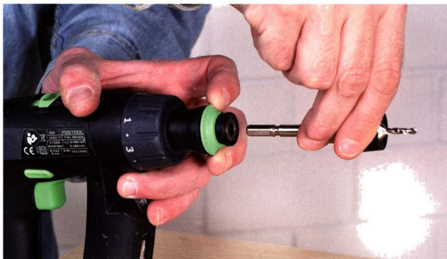
Dann den grünen Ring nach hinten ziehen und das gewünschte Werkzeug mit CENTROTEC<sup>®</sup>-Aufnahme einstecken. Die Kugelführung innerhalb des Futters sorgt für eine 10 mal bessere Rundlaufgenauigkeit als bei einem Standardbithalter.
