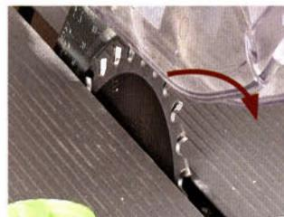
Zur Schrägstellung des Sägeblatts muss zuerst ein Feststell-drehknopf gelöst werden. Dann lässt sich das Sägeblatt zwischen den beiden Endanschlägen mithilfe eines Drehknopfs oder Drehrads von 0° bis max. 45° nach rechts schwenken. Die Schräge lässt sich über einen Zeiger an einer Winkelskala genau ablesen. Für genaue Einsparbeiten kann das Sägeblatt bei einigen Modellen sogar um jeweils 2° über die beiden Endanschläge hinaus geschwenkt werden.
