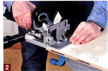
Um einen variablen Abstand einzustellen, liegt vielen Maschinen ein solcher Anschlagwinkel bei. Er wird auf den Schwenkanschlag geschoben und lässt sich dort mithilfe einer Skala genau auf die gewünschte Höhe einstellen und fixieren.
