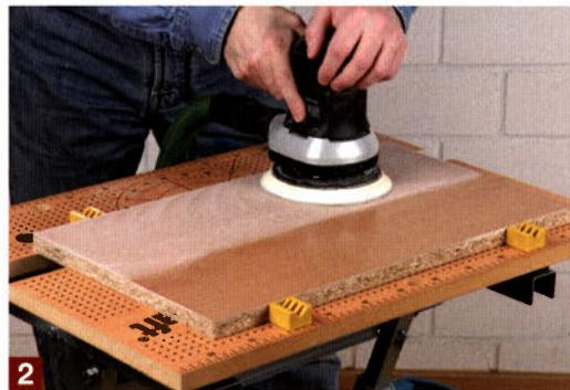
Dazu benutzen Sie den Exzentrerschleifer mit Titan 2 P 800er Schleifpapier. Die Maschine immer vollflächig aufliegen lassen und nicht an den Enden abkippen.
