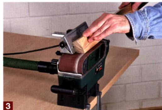
Der Anschlag lässt sich durch umstecken aber auch quer über dem Schleifband befestigen. Durch die Drehbewegung des Schleifbands wird das Werkstück dann automatisch auf die Anschlagfläche gedrückt. Das ist vor allem bei kleinen und runden Werkstücken ein großer Vorteil. Denn ein solches Rad wäre bei dem in Bild 3 montierten Anschlag nicht mehr festzuhalten und würde (angetrieben durch das Schleifband) wie ein Geschoss durch die Werkstatt fliegen!
