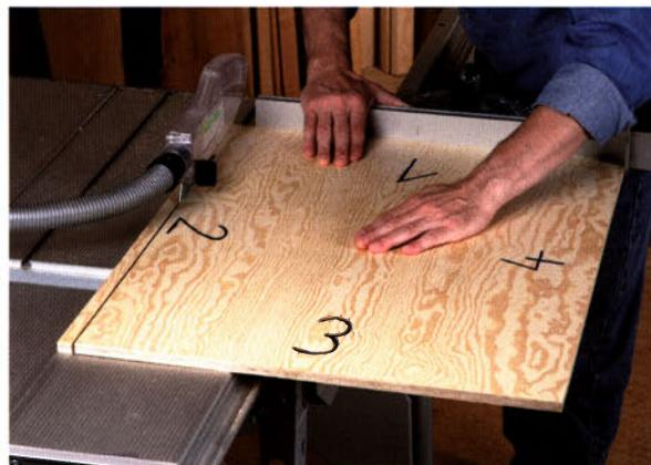
Nachdem von den Kanten 4 und 1 ebenfalls ein schmaler Streifen abgesägt wurde, wird die Platte wieder auf die Anfangsposition gelegt und von der Kante 2 ein ca. 20–30 mm breiter Streifen abgesägt.
