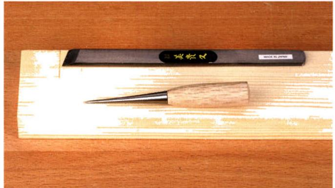
Ein scharfes Anreißmesser zerschneidet die Holzfasern und ist dem groben Riss einer Reißnadel oder eines Stechahls haushoch überlegen.
