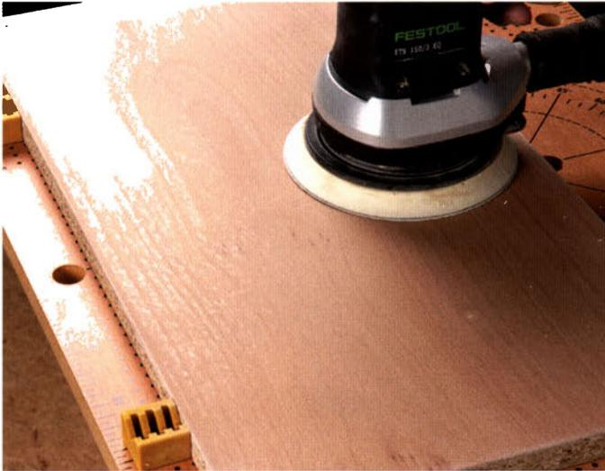
Bearbeiten Sie anschließend die Oberfläche mit dem P 1500er Schleifpapier, bis die gesamte Fläche frei von Unebenheiten ist.
