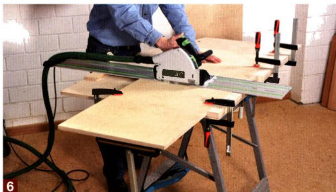
Fixieren Sie auch den Abschnitt des Werkstücks mit einigen Zwingen, damit er beim Absägen nicht verrutscht. Dann können Sie diese Sägekante gleich wieder als Anlagekante für das Anschlagbrettchen nutzen.
