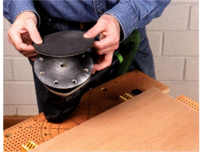
Selbst letzte minimale Unebenheiten werden von der flexiblen Oberfläche des 2000er Platin 2 Schleifpads erreicht.
