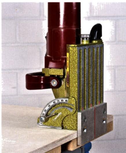
Der Markführer und Erfinder hatte das Problem schon vor 40 Jahren gelöst indem er einfach eine Metallplatte mitlieferte, die mit zwei Schrauben einfach unter dem Gehäuseboden befestigt wurde.
