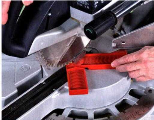
te funktionieren. Dazu besitzen diese Spezialschmiegen lange symmetrisch laufende Schenkel und eine lange Mittelschiene, die automatisch immer die Winkelhalbierende anzeigt. Die Preise für solche Schmiegen beginnen bei einfachen Modellen bei etwa 15 Euro (z. B. HEDÜ Winkelmesser) und können je nach Ausführung auch über 100 Euro betragen. Auf jeden Fall verliert jede Gehrung mit einer solchen Winkelschmiege ihren Schrecken.
