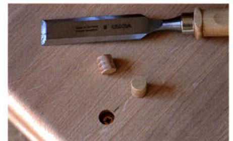
Stecken Sie anschließend den Dübel mit Leim in das Bohrloch und stechen Sie den Überstand mit einem scharfen Stechbeitel ab. Zum Schluss wird die gesamte Platte geschliffen und wenn der Dübel passend zur Holzfläche ausgewählt wurde, ist er nur noch für „Eingeweihte“ erkennbar (Pfeil).
