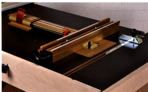
Wenn Sie den Fräsanschlag der Fa. Inkra einsetzen möchten, benötigen Sie für die Befestigung auf der Tischfläche lediglich vier 6,5-mm-Bohrungen (Maße dazu finden Sie in der Zeichnung). Sie können das auch später bei Bedarf noch nachholen und zunächst den Selbstbau-Fräsanschlag nachbauen und einsetzen.
