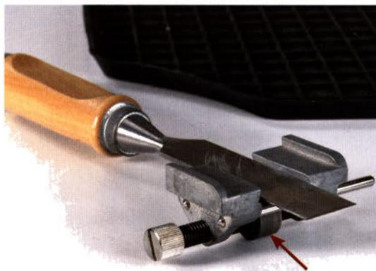
Ein absolutes Muss beim Handschärfen ist eine Schleifführung. Dort wird die Klinge zuerst zwischen zwei verstellbare Backen eingespannt und beides mithilfe eines kleinen Rädchens (Pfeil) über den Schärfstein geschoben.
