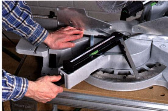
Wenn Sie den Klemmhebel nach oben geschwenkt haben, können Sie über den Drehgriff in der rechten Führungsstange das Sägeaggregat sehr feinfühlig zur Seite neigen. Auch die vertikalen Winkel können über eine sehr präzise Skala abgelesen werden.
