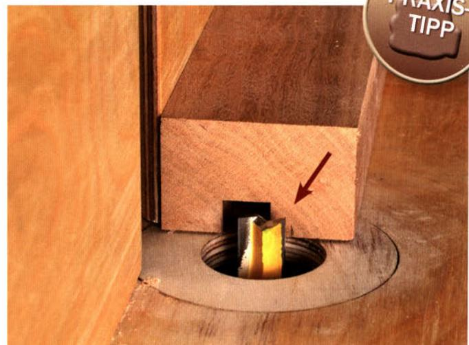
Achten Sie aber unbedingt darauf, dass Sie die Nut vom Anschlag weg verbreitern (Pfeil), sonst fräsen Sie nicht mehr gegen die Laufrichtung des Fräasers (Gegenlaufräsen).
