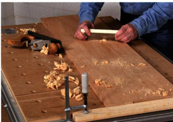
Den ausgehärteten Leim auf einer Leimholzplatte sollten Sie zuerst mit einer Ziehklinge entfernen, bevor Sie zum Schluss die Fläche noch einmal „fein“ mit dem Putzhobel bearbeiten. Sie schonen auf diese Weise die mühsam geschärften Messer und die Sohle des Putzhobels.
