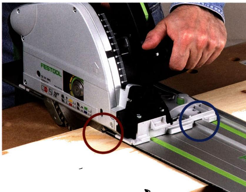
Tauchsäge mit Führungsschiene
