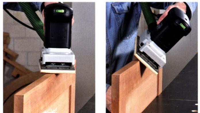
Beim Schleifen von Rahmenkanten (oben) sollten Sie mit der Maschine auf keinen Fall die scharfen Kanten brechen (unten), denn das hinterlässt tiefe Riefen im Schleifschuh.
