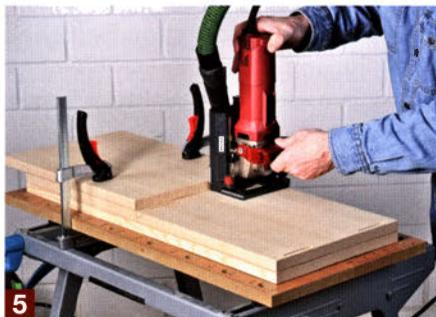
... und festspannen. Danach die Fräse zuerst hochkant an die Brettkante legen und je zwei Schlitz in die Seitenwand fräsen.
