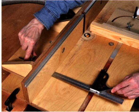
Bei rechtwinkligen Rahmen muss auch der Queranschlag genau rechtwinklig zum Fräsanschlag eingestellt werden.
