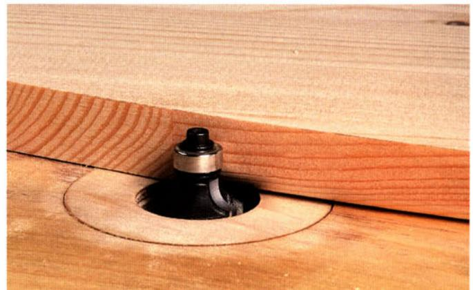
Um anschließend die Kanten noch abzurunden oder mit einem Profil zu versehen, wird keine Schablone mehr benötigt. Es muss sich lediglich ein Kugellager am Fräser befinden.
