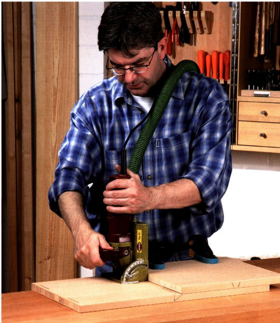
T-Verbindung leicht gemacht. Einfach Werkstück mit Zwingen positionieren, Fräse an der Werkstückkante anlegen und je zwei Schlitzte fräsen – fertig!
