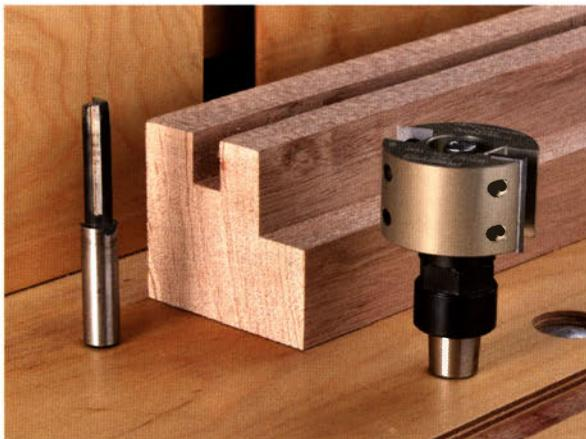
Mit einem Nutfräser (li.) können Sie natürlich auch falzen. Der größere Falzkopf (re.) fräst aber mit einer höheren Schnittgeschwindigkeit und durchtrennt die Fasern in einem flacheren Winkel.
