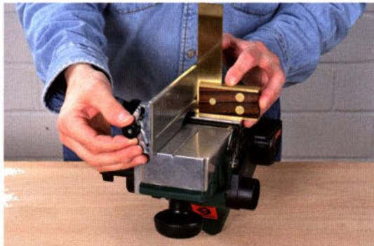
Für den kleinen Falztiefenanschlag befindet sich auf der anderen Seite des Hobels ebenfalls eine passende Auskerbung. Zur Einstellung der Falztiefe zuerst die Spanabnahme auf 0 stellen (Hobelsohle hat dann durchgehendes Niveau). Dann mit einem Meterstab den Abstand zwischen Tiefenanschlag und Hobelsohle auf die gewünschte Falztiefe einstellen. Spanabnahme auf Maximum einstellen und zum Schluss noch die gewünschte Falzbreite durch verschieben des Winkelanschlags festlegen.
