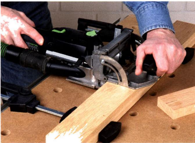
So einfach geht's: Maschinenanschlag auf das Werkstück legen und ausrichten, Fräse einschalten und Motorgehäuse samt Fräser langsam und gleichmäßig nach vorne schieben.
