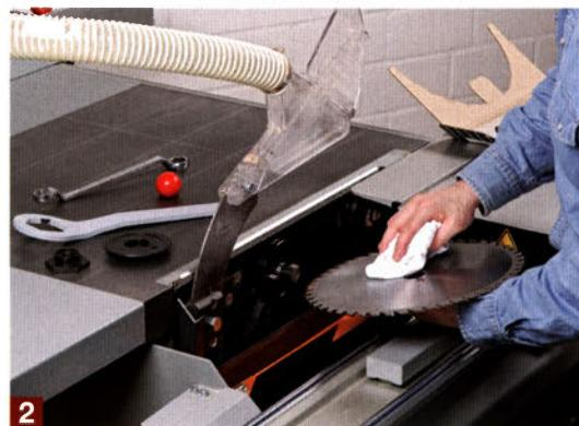
„So wie ich lauf, so geh ich auf.“ Zum Öffnen der Mutter also einfach den Schlüssel in Richtung der Sägeblattzähne drehen (Bild 1). Anschließend das neue Sägeblatt und die komplette Sägeblattaufnahme gut säubern. Beides muss völlig frei von Staub und Spänen sein (Bild 2).
