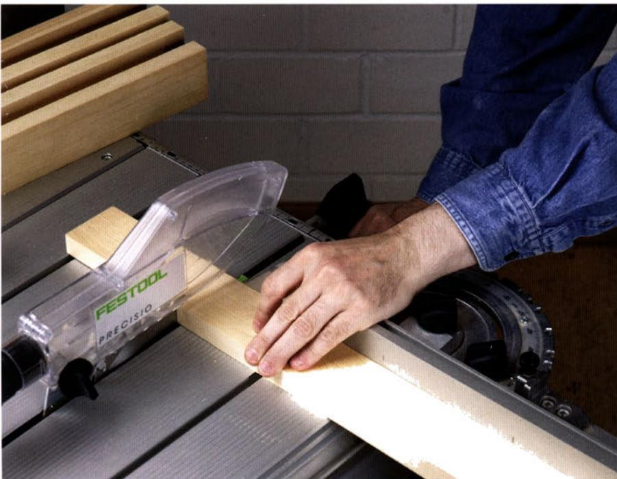
Da das Werkstück auf dem Säge Tisch ruht, während das Sägeblatt mittels Zughebel ins Holz fährt, können Werkstücke die nicht zu lang oder zu kurz sind noch gefahrlos mit einer Hand gehalten werden.
