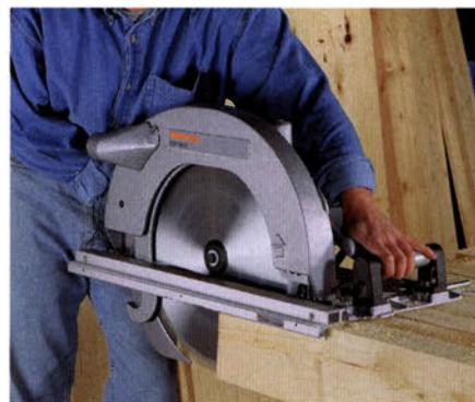
Manche meinen, dass diese Säge nur etwas für „harte Männer“ ist. In jedem Fall ist es aber wirklich beeindruckend, mit welcher Leichtigkeit das 420 mm große Sägeblatt durch den 150 mm dicken Balken gleitet. Foto: Protocol
