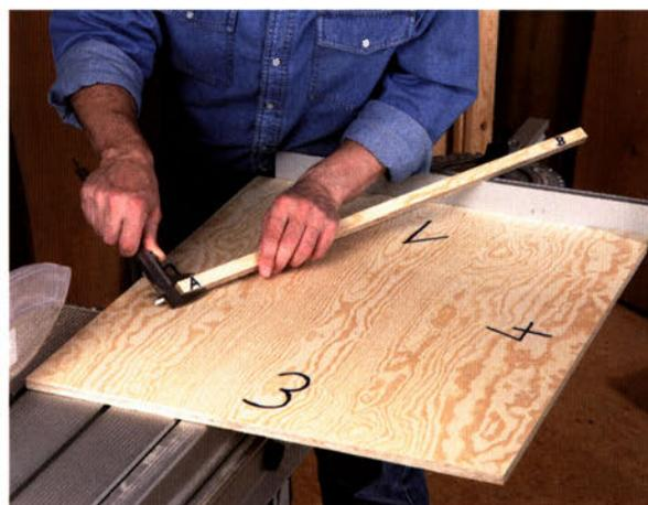
Kennzeichnen Sie das vordere Ende des Streifens mit einem A und das hintere mit einem B. Messen Sie beide Enden mit einem Messschieber nach. Sind beide Enden gleich ist der Anschlagswinkel der Kreissäge exakt  $90^\circ$ .
