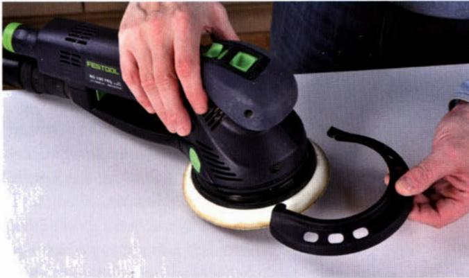
Damit der schnell rotierende Schleifteller keine benachbarten Randflächen und dabei auch sich selbst beschädigt, gibt es zu diesem Modell einen speziellen Kunststoffschutz (Protector), der einfach in eine Nut oberhalb des Schleiftellers gesteckt wird.
