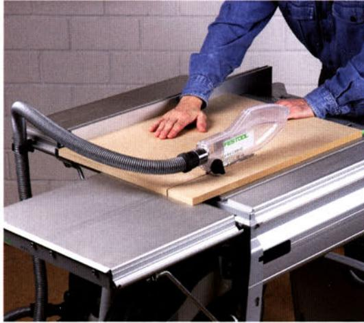
Bei Werkstücken, die schmäler als 12 cm sind, muss unbedingt ein Schiebestock benutzt werden. Denken Sie immer daran, ein Schiebestock ist ersetzbar – die Hand bzw. Finger nicht! Am besten stellen Sie sich aus Resthölzern zwei bis drei Schiebestöcke selbst her. Als Muster benutzen Sie einfach den mitgelieferten Schiebestock. So haben Sie bei Beschädigung schnell einen Ersatz zur Hand.
