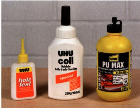
Die Spezialisten (von links): Extrem verdünnter Holzleim gegen „wackelige Verbindungen“ ohne sie auseinander nehmen zu müssen, ein spezieller „Lackleim“, der auch auf lackierten und kunststoffbeschichteten Platten eingesetzt werden kann und ein Polyurethan-Kleber, der im Gegensatz zum Holzleim auch spaltfüllend klebt.
