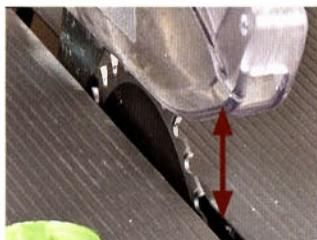
Wie hoch das Sägeblatt aus dem Tisch herausragt, lässt sich über eine kleine Kurbel an das zu bearbeitende Werkstück anpassen (vgl. Abbildung gegenüberliegende Seite). Die Zähne des Sägeblatts dürfen nur maximal 10 mm über das Werkstück herausragen. Und die Spanhaube darf nur bei verdeckten Schnitten entfernt werden.
