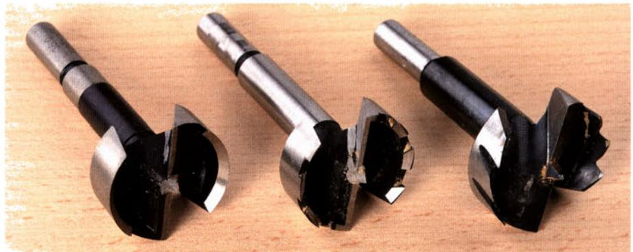
Bei normalen Forstnerbohrern (links) entsteht an der großen Schneidfläche schnell eine hohe Reibungshitze, die zum Ausglühen der Schneiden führt. Bei neueren Modellen (mitte und rechts) sind die Schneiden deshalb unterbrochen oder gezahnt, was die Gefahr des Ausglühens erheblich reduziert und die Standzeit (Schärfe) deutlich erhöht. Auch der benötigte Druck beim Bohren der Löcher ist um ein vielfaches geringer als bei herkömmlichen Forstnerbohrern.
