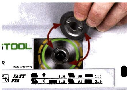
Setzen Sie das neue Sägeblatt mit der Farbcodierung und der Schrift nach außen wieder in die Säge ein. Stecken Sie dann den Flansch ...
