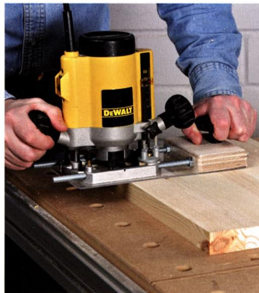
Zwei die in jede Holzwerkstatt gehören: Eine Flachdübelfräse (links) ist ein absolutes Muss im Möbelbau. Mit den flachen Plättchen können Sie schnell und präzise Holzplatten zu Korpusmöbeln verbinden. Und mit der Oberfräse (rechts) werden aus den „scharfen“ Plattenkanten im Nu gleichmäßig gerundete Handschmeichler – einfach zauberhaft!
