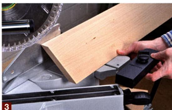
Mit der Winkelabstützung kann die gleiche Kranzleiste ohne die vertikale Schwenkung des Sägeblatts also in „original Wandlage“ zugeschnitten werden. Dazu wird das Sägeaggregat nur ...
