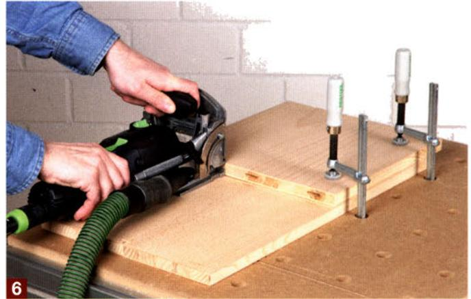
6 Erst danach legen Sie die Fräse flach auf die Seitenwand und fräsen die Schlitzlöcher in den Boden. Beachten Sie unbedingt diese Reihenfolge, denn beim zweiten Fräsgang könnte der Boden möglicherweise ein wenig verrutschen.
