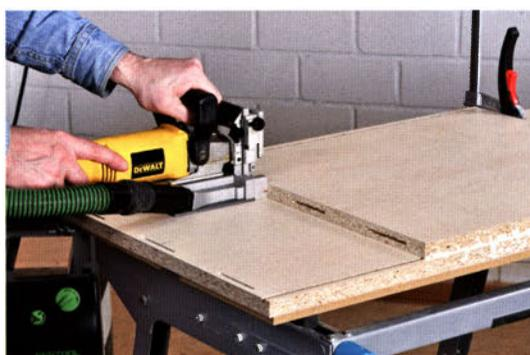
... der Maschine ist nicht mehr möglich. Sind alle Seitenwände gebohrt, Platte wieder entfernen und die Böden fräsen.
