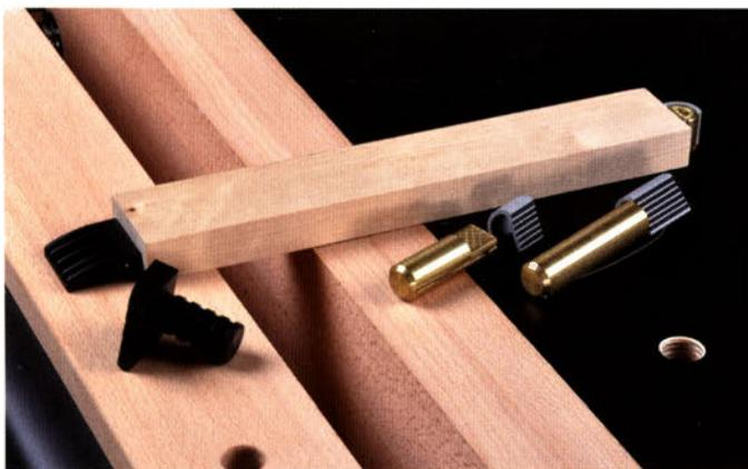
Sogenannte Bankhaken gibt es aus Messing, Stahl oder Kunststoff. Sie werden einfach in die Bohrung gesteckt und klemmen das Werkstück an den Kanten ein. Da die Bankhaken selbst keinen Spannmechanismus besitzen, erfolgt die Spannkraft in der Regel über die Spindel der Vorderzange. Dazu wird ein Haken in ein Loch der Vorderzange und ein weiterer in ein Loch der Tischfläche eingesteckt.
