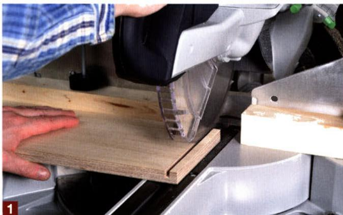
Stellen Sie die gewünschte Schnitttiefe wieder über den Kapptiefen-Hebel ein und sägen Sie mit zwei Sägeschnitten eine ca. 6 mm breite und 6-8 mm tiefe Nut heraus.
