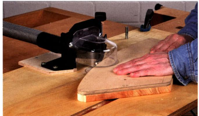
Benutzen Sie die Führungskante wie eine Rampe zum Fräser. Bewegen Sie dann das Werkstück gleichmäßig immer von rechts nach links am Fräser vorbei – niemals umgekehrt – sonst entstehen gefährliche Rückschläge!
