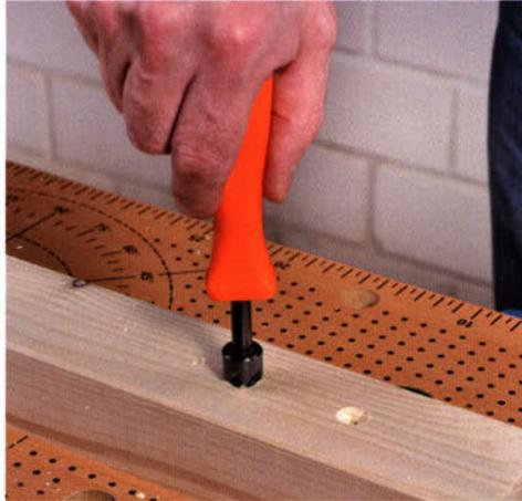
Mit einem Handsenker können Sie schnell und einfach Bohrlöcher ansenken oder entgraten. Dazu wird er im Bohrloch mehrmals hin und her gedreht, bis die gewünschte Tiefe der Senkung erreicht ist. Das geht im Holz trotz des Handbetriebs wirklich sehr zügig und wenn Sie nur mal eben ein bis zwei Löcher ansenken möchten, sind Sie mit dem Handsenker schon fertig, bevor Sie den Maschinensenker im Bohrfutter eingespannt haben.
