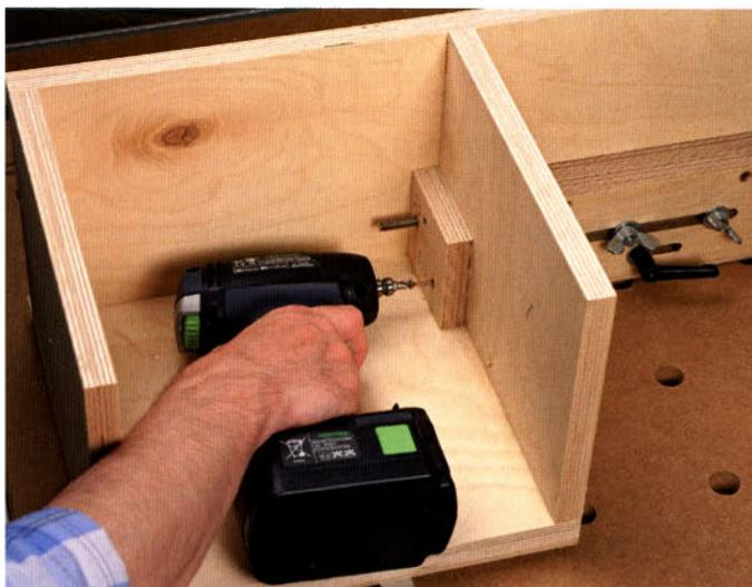
Bei einigen Akkuschaubern können Sie das Bohrfutter entfernen und die Schrauber Klinge (Bit) direkt in die vordere Aufnahme stecken. Ideal, wenn es mal ganz eng wird und man keinen Winkelvorsatz zur Hand hat.
