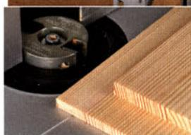
Die Füllung wird zuerst mit einem breiten Falzfräser so „abgeplattet“ bzw. gefälzt, dass sie genau in die 8-mm-Nut passt (Abplattung-/Falztiefe ca. 25 mm).
