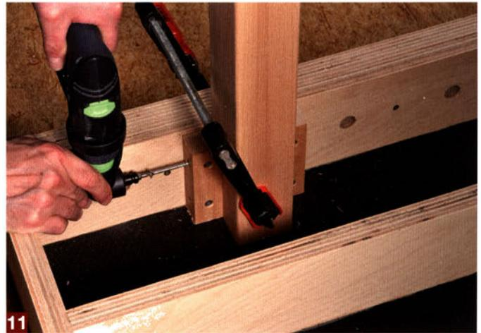
Legen Sie die Werk Tischplatte umgedreht auf den Boden, stecken Sie das komplett montierte Gestell zwischen die Zargen und verschrauben Sie es dort mit Eckleisten. Im Bereich der Spannzanze müssen Sie die Gegenlager der Hobelbankspindeln etwas in die Fußenden einlassen.
