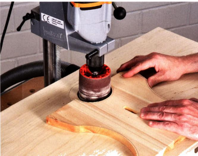
Schleifen: Mit runden Schleifhülsen wird der Bohrständler im Nu zur stationären Schleifmaschine – ideal für geschweifte Werkstücke.
