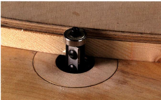
Während das Kugellager die Schablonekante „abtastet“, fräsen die Schneiden den Überstand des Werkstücks bündig zur Schablone. Der Überstand sollte aber nie mehr als 3 mm betragen.
