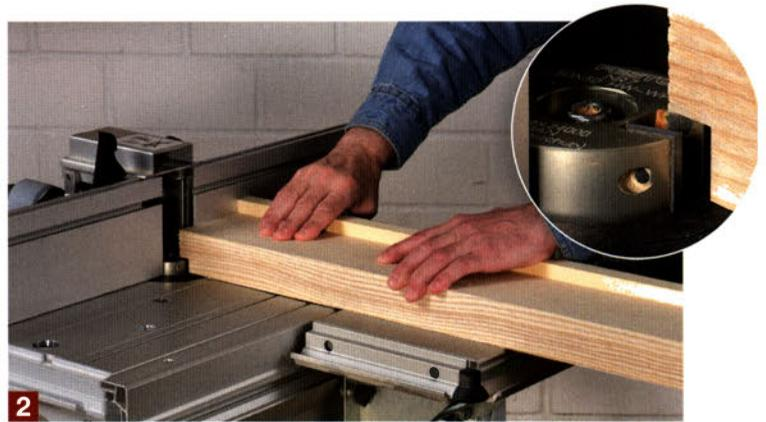
**2** Danach wird der obere Querrahmenfries auf einem Frästisch an den Stirnenden 15 mm hoch und 12 mm tief ausgefäلت.
