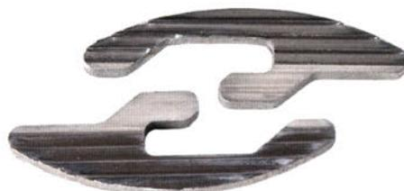
Der Simplex Verbinder ist ein 2-teiliges und aushängbares Verbindungselement aus Aluminium. Die Montage ist jedoch etwas knifflig und sollte mit dem passenden Einschlagwerkzeug und einem 2-Komponentenklebstoff erfolgen.
