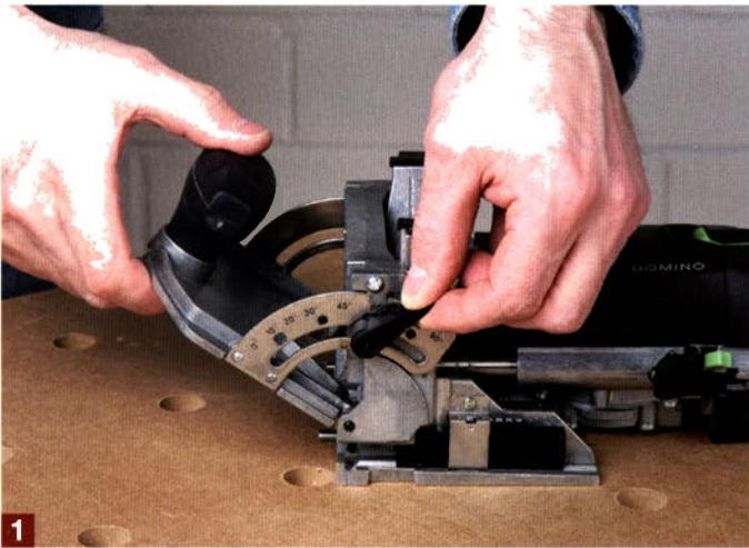
**1** Der Anschlag ist von 0 – 90° stufenlos schwenkbar, wobei er bei den wichtigsten Gradwerten 22,5°, 45° und 67,5° präzise einrastet.
