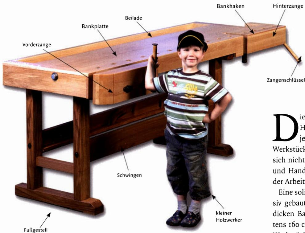
Die Hobelbank ist der ideale Werk Tisch für die Holzbearbeitung und der zentrale Arbeitsplatz in jeder Holzwerkstatt. Sie bietet die Möglichkeit, Werkstücke bei der Bearbeitung festzuspannen, wodurch sich nicht nur die Sicherheit im Umgang mit Maschinen und Handwerkzeug erhöht, sondern auch die Präzision der Arbeit deutlich verbessert.
