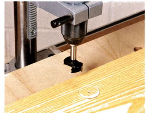
Mit einem großen Forstnerbohrer können Sie ebenfalls die Rechtwinkligkeit überprüfen. Bohren Sie dazu nur ein leicht angeritztes Loch. Ist der Kranz, den der Bohrer hinterlässt, nicht absolut gleichmäßig, sondern wie hier (Bild oben) im vorderen Bereich etwas tiefer, dann muss die Multiplexplatte im Bereich der Bohrsäule angehoben werden. Sieht der Kranz gleichmäßig aus (Bild links: Kreis 1) bohrt der Bohrstander absolute senkrechte Löcher.
