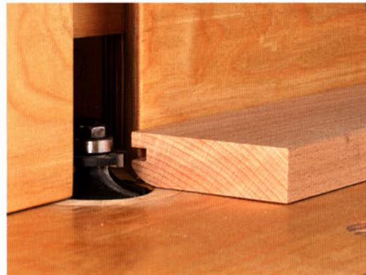
Beim Konterprofil müssen Sie zuerst immer die Stirnkanten der Querrahmenhölzer fräsen. Bei diesem Profil sollte Die Holzstärke zwischen 19 und 21 mm betragen.
