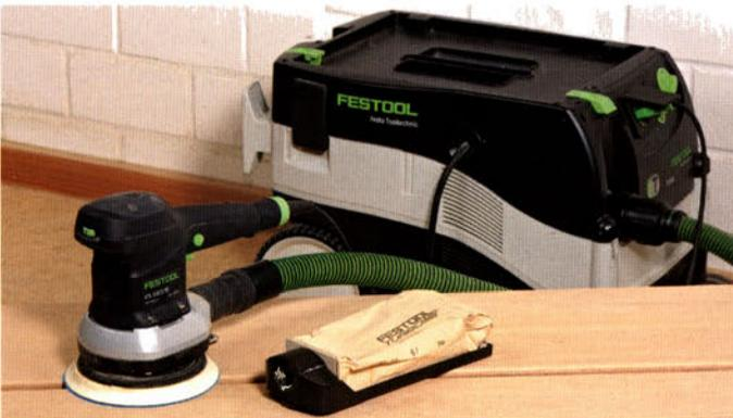
**Immer mit aktiver Staubabsaugung** schleifen anstelle des einfachen Staub-sacks. Denn der Sauger hält die Fläche frei von Staub und ausgebrochenen Schleifkörnern und erhöht somit die Standzeit des Schleifpapiers um ein Vielfaches.
