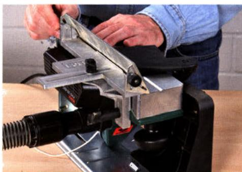
Sinnvoll ist zudem die Montage des Winkelanschlags, damit Sie z. B. die beiden benachbarten Flächen einer Leiste genau rechtwinklig zueinander aushobeln können. Der Anschlag lässt sich aber auch problemlos bis 45° schräg stellen.
