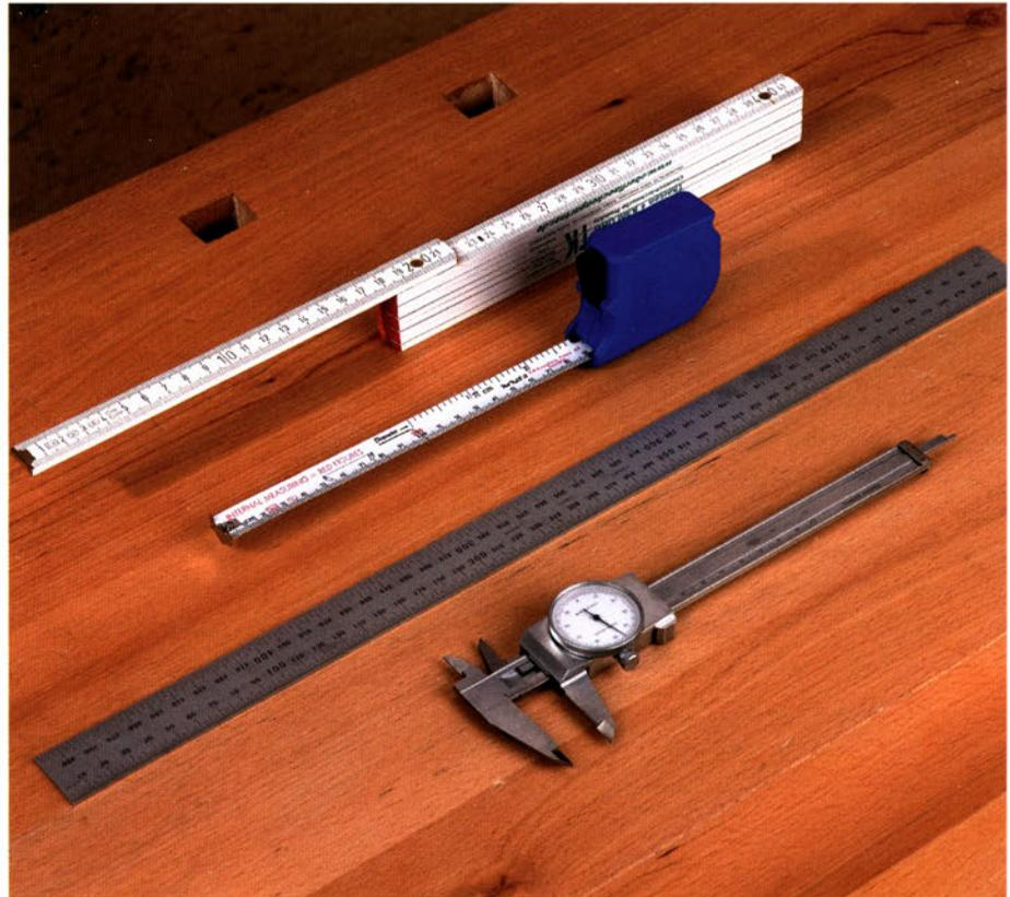
Mit dieser Ausstattung sind sie für alle Messaufgaben bestens gerüstet: Der Zollstock für normale Messarbeiten, sollte durch ein gutes Bandmaß mit seinen sinnvollen Zusatzfunktion ergänzt werden. Für besonders genaues Arbeiten sollten Sie dann noch ein hochwertiges Stahllineal mit tiefgeätzt oder besser noch eingravierter Skala anschaffen. Den Messschieber brauchen Sie, wenn es um den Zehntel- bzw. Hundertstelmillimeter geht.
