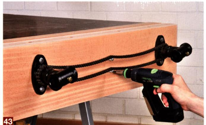
43 Dann die Kette auflegen und wenn nötig mit den Kunststoffhülsen das Durchhängen etwas abfangen. Kettenabdeckung und Zangenschlüssel erst montieren, wenn die gesamte Werkbank fertig auf dem Untergestell sitzt.
