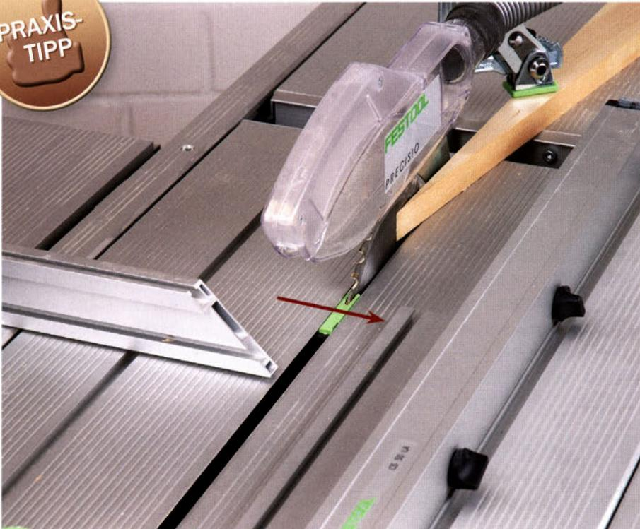
Zum Ablängen kurzer Werkstücke oder wenn Sie beispielsweise von einer schmalen Holzleiste mehrere gleich kurze Holzklötzchen abschneiden möchten, wird zunächst die Anschlagsschiene des Parallelanschlags so weit zurück gezogen, bis das hintere Ende vor dem Sägeblatt liegt (Pfeil). Auf diese Weise können sich keine Abfallstücke zwischen Anschlag und Sägeblatt verklemmen.
