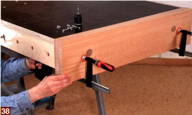
38 Die hintere Spannbacke wird einfach von unten mit der Tischzarge verschraubt. Ein paar Flachdübel an der Tisch- und der Backenoberkante erleichtern die Befestigung.
