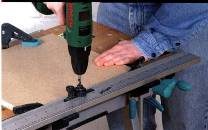
1. Setzen Sie beim Bohren durch eine Führungsbuchse (Bohrbuchse aus Metall) immer einen Metallbohrer ein und keinen Holzbohrer mit Zentrierspitze!
