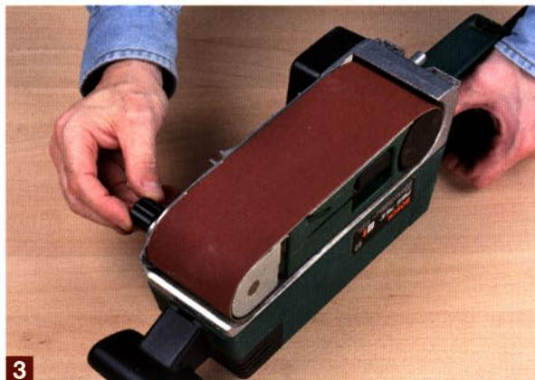
Beim Bandschleifer läuft ein Endlos-schleifband mit einer relativ hohen Geschwindigkeit über zwei Rollen. Die hintere am Schalter befindliche starre Rolle sorgt für den Antrieb des Bands, während die vordere, federgelagerte Rolle für die Bandspannung und den mittigen Bandlauf zuständig ist.
