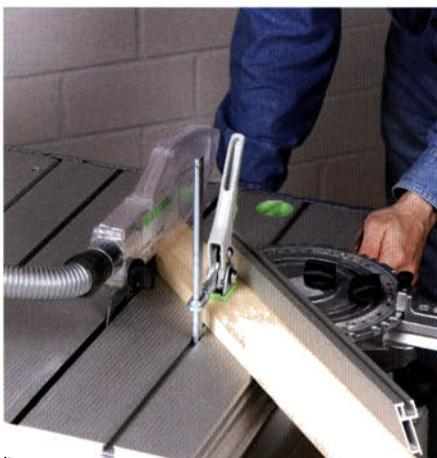
Rahmenhölzer zum Bau von Möbeltüren oder Bilderrahmen können hervorragend mit dem auf  $45^\circ$  eingestellten Winkelanschlag passgenau auf Gehrung zugeschnitten werden.
