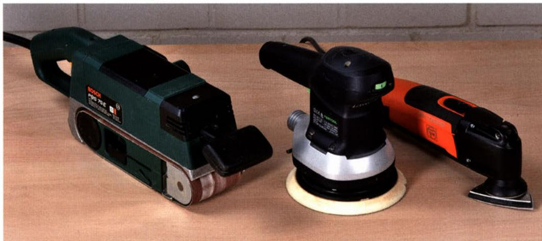
Die drei wichtigsten Schleifmaschinen, mit denen Sie in der Regel alle in der Holzwerkstatt anfallenden Schleifarbeiten erledigen können (von links nach rechts): der kraftvolle Bandschleifer, der feinfühlige Exzentrerschleifer und die vielseitige, oszillierende Säge als Dreieckschleifer.
