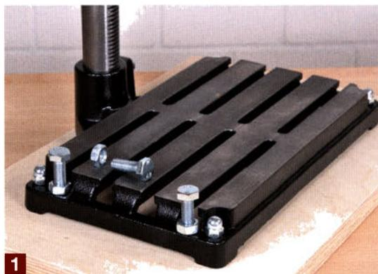
In der Grauguss-Grundplatte befinden sich 8 T-Nut-Schlitze passend für M10er Schrauben und Mutter. An den Ecken befindet sich noch je eine Bohrung um die Gussplatte auf der Werkbank oder auf einer Holzplatte festzuschrauben.
