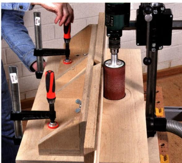
Legen Sie das zu schleifende Brett zwischen Winkelanschlag (hier ein Frästischanschlag) und Schleifhülse. Drücken Sie anschließend den Winkelanschlag zusammen mit dem Brett dicht gegen die Hülse und fixieren Sie dann den Anschlag mit Zwingen auf der Schleifstation. Ziehen Sie zum Schluss das Brett wieder heraus.
