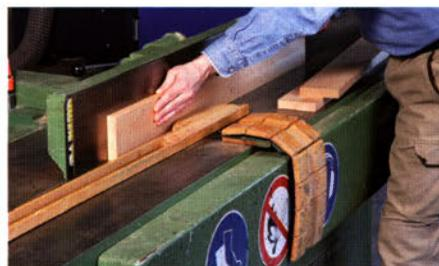
Möchten Sie schmale Bretter zu einer großen Leimholzplatte verleimen, müssen die Kanten auf einer Abrichthobelmaschine zuerst gerade gehobelt werden. Dabei das Schreinerdreieck immer wechselseitig gegen den Anschlag legen, dann muss dieser nicht genau rechtwinklig stehen.
