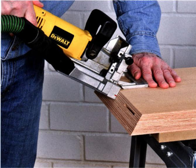
Mit diesen Maschinen können Sie dann auch bei anderen Winkeln als 45° die Schlitzhöhe in der Kante stufenlos über den Schwenkansschlag einstellen.
