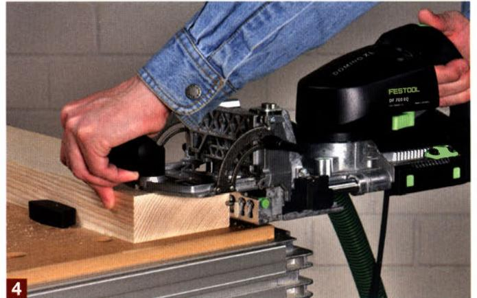
**4** Anschließend mit der gleichen Einstellung auch die passenden Gegenlöcher in die beiden aufrechten Blendrahmenteile fräsen.
