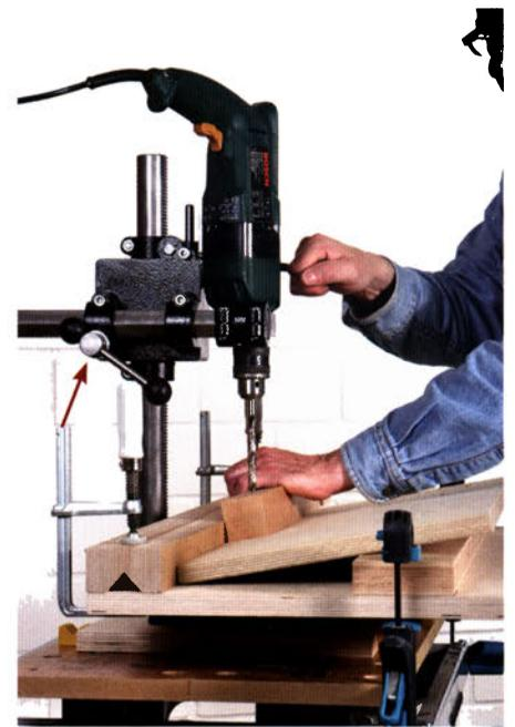
Mit dem Auslegerhebel (Pfeil) können Sie den Auslegerarm präzise per Zahnrad vor und zurück bewegen und so den eingespannten Bohrer genau auf dem Werkstück ausrichten.
