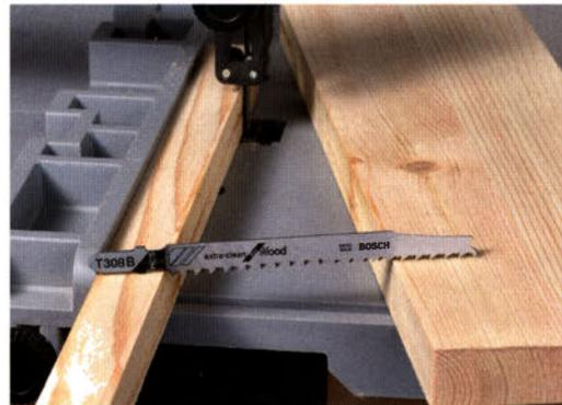
... an den Schnittkanten sind nicht vorhanden. Die Schnittqualität ist für eine Stichsäge wirklich erstaunlich hoch und bedarf keiner Nacharbeit mehr – unbedingt ausprobieren!
