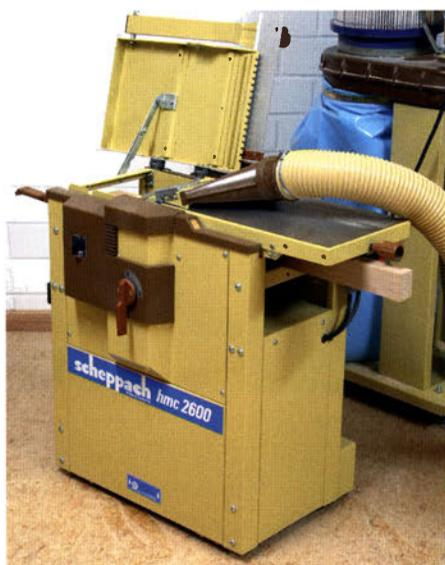
Eine stationäre Hobelmaschine ist nicht nur leistungsfähiger als ein Elektrohobel, sondern durch die langen Abrichttische gelingen auch problemlos planebene Flächen (links). Zudem können Sie die zuvor plangehobelten und abgerichteten Flächen nach ein paar Umbaumaßnahmen auch gleich auf ein bestimmtes Dickenmaß hobeln (rechts).
