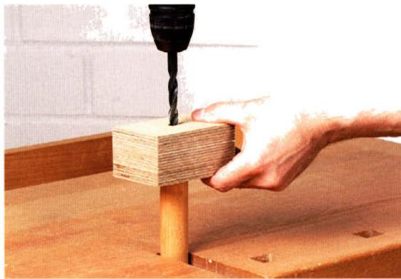
Zuerst auf dem Bohrständler ein Sackloch im Durchmesser des Rundstabs bohren. Danach mit dem passenden Dübelbohrer den Rest durchbohren (oben). Anschließend den Holzklotz auf den Rundstab stecken und das gewünschte Dübelloch bohren.
