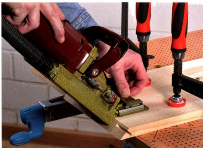
Legen Sie beide Sockelblenden nebeneinander und sichern Sie beide mit Zwingen gegen verrutschen. Stellen Sie die Frästiefe der Maschine auf „S“ ein und benutzen Sie bei Gehrungen unbedingt die 4 mm dicke Aufsteckplatte.
