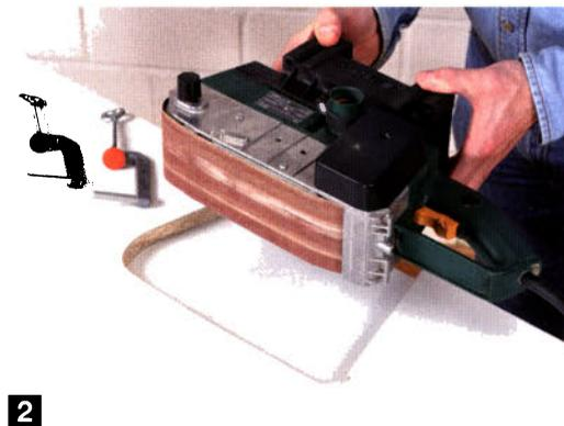
Sägen Sie in die Längskante einer 19 mm dicken Spanplatte die Außenkontur Ihres Bandschleifers (zzgl. etwa 3–5 mm Luft). Schrauben Sie dann eine weitere 19 mm dicke Spanplatte darauf (1). Entfernen Sie vom Bandschleifer den Zusatzgriff und legen Sie ihn zusammen mit dem Untergestell in die Aussparung (2) ...
