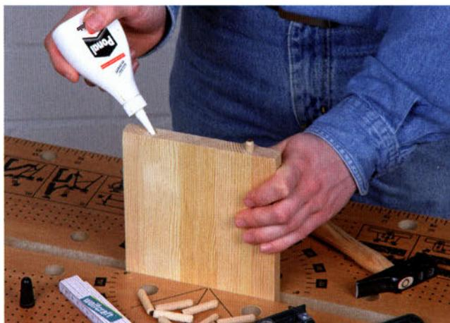
Leimen Sie die Dübel immer zuerst in die Stirnbohrungen und achten Sie darauf, dass die Dübel nur max.  $\frac{2}{3}$  der Holzstärke vorstehen dürfen.
