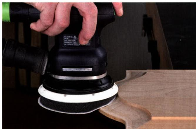
Mit einem flexiblen, dicken Schaumstoff-Pad (Interface-Pad) können Sie auch stark gewölbte Bauteile schleifen. Es besitzt auf der einen Seite einen Velourbelag, der auf dem Schleifteller haftet und auf der anderen Seite einen Klettbelag für das Schleifpapier.
