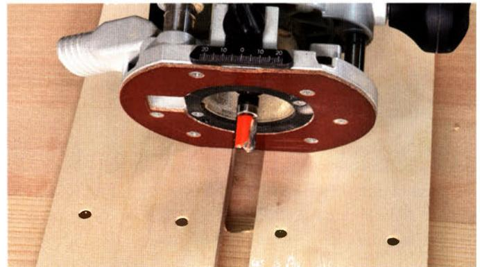
Jetzt können Sie mit dem in Bild 9 gezeigten Bündigfräser – einmal links und rechts am Multiplex anliegend – eine präzise zum Alurohr passende Nut einfräsen.
