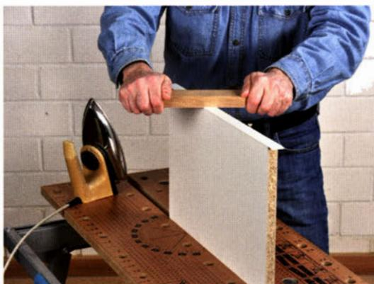
Reiben Sie sofort nach dem Aufbügeln mit einem Hartholzklötz über die Kante, damit die Hitze etwas abgeleitet wird und die Kante unter Druck abkühlen kann. Dadurch verbindet sich auch der erwärmte Schmelzkleber noch besser mit dem Umleimer und der Plattenkante.
