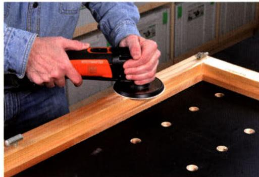
Die perfekte Kombi: Mit dem dreieckigen Teller schleifen Sie Ecken und Falzflächen nach. Die größeren Rahmenflächen schleifen Sie zügiger und gleichmäßiger mit dem runden Schleifteller.
