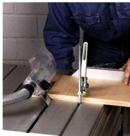
Sollen Brettenden auf Gehrung gesägt werden, um beispielsweise einen Korpus zu fertigen, wird nicht der Anschlag, sondern diesmal das Sägeblatt um  $45^\circ$  geschwenkt.
