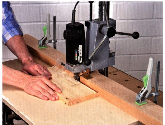
Fräsen: Mit einem Fräsmotor mit Eurohalsaufnahme wird der Bohrständler sogar zur stationären Tischfräse mit unbeschränkter Sicht auf Fräser und Werkstück.
