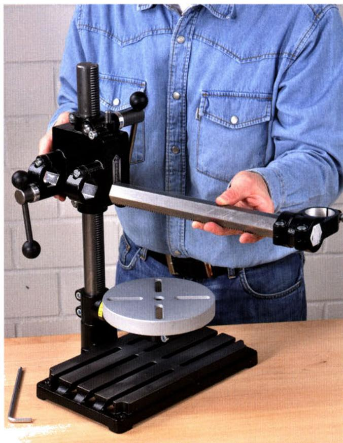
Soll der schwenk- und drehbare Rundteller benutzt werden, muss er als erstes auf die Bohrsäule geschoben werden. Anschließend stecken Sie die Säule in die Grundplatte und den Sechskant-Auslegerarm in die entsprechende Aufnahme an der Bohrsäule.
