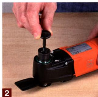
2 Spannschraube einfach abziehen
