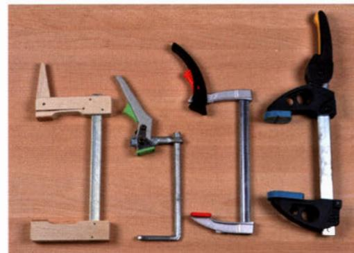
Exzenterzwingen erzeugen den Pressdruck über einen exzentrisch gelagerten Hebel (ganz links: Klemmzwinde aus Holz).
