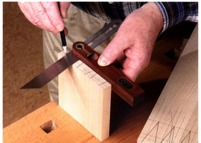
Mit einer Schmiege lassen sich auch Zinken- oder Schwalbenschwänze – je nachdem was Sie zuerst herstellen – schnell und präzise anzeichnen.
