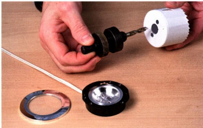
Die Bi-Metall-Lochsägen gibt es in zahlreichen Durchmessern von 14 – 152 mm, sie werden einfach auf das Gewinde des Aufnahmedorns gedreht und von hinten mit zwei Stiften gesichert.
