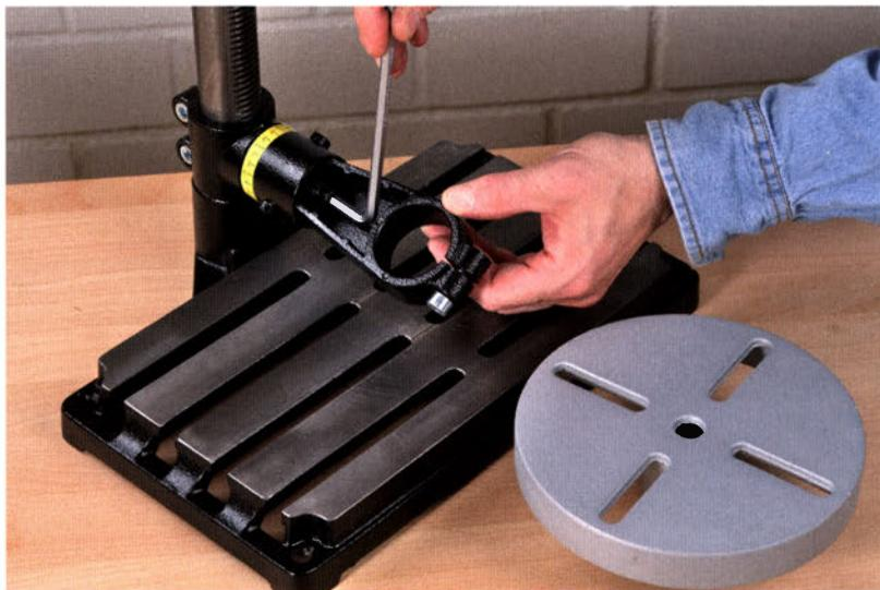
Die Rundtelleraufnahme lässt sich leider nur in festen 15°-Schritten nach links oder rechts schwenken, der eingesteckte Rundteller selbst ist stufenlos um 360° drehbar.
