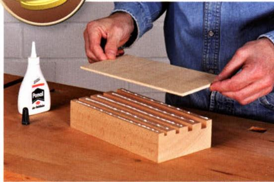
Unter die Box schrauben Sie ein langes Sperrholzbrett, damit Sie das Ganze mit Zwingen auf dem Säge Tisch befestigen können. Die Dübellänge wird durch ein dünnes Holzbrettchen festgelegt, das einfach in den passenden Schlitz geschoben wird.
