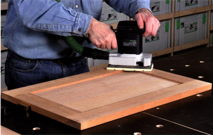
Aufgrund der ruhigen Schwingbewegung lässt sich ein Schwingschleifer schön plan auf der Holzfläche führen. Er neigt nicht so sehr zum Abschleifen der Werkstückenden wie es beispielsweise bei einem rotierenden Exzentrerschleifer oft der Fall ist.
