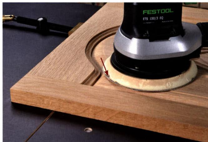
Beim Schleifen eines Rahmens mit zurückliegender Füllung stößt der rotierende Schleifteller sehr schnell gegen das Rahmenprofil und beschädigt dabei sich (Pfeil) und das Werkstück. Achten Sie deshalb bei der Türkonstruktion darauf, dass die Außenflächen von Rahmen und Füllung möglichst immer auf einer Ebene liegen.
