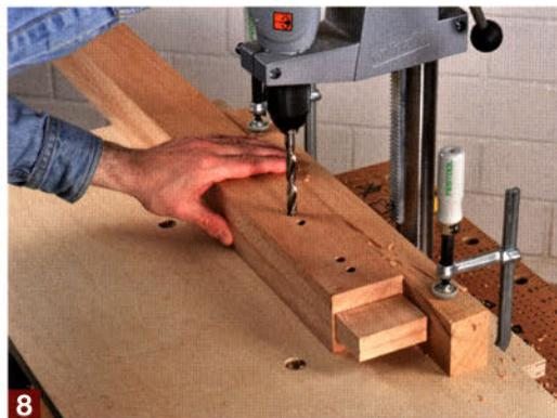
Nachdem Sie in die GestellfüÙe noch die Dübel- und Gewindelöcher gebohrt haben, werden sie mit den Fußbalken verleimt. Achten Sie hier unbedingt auf die Rechtwinkligkeit der FüÙe zum unteren Balken.
