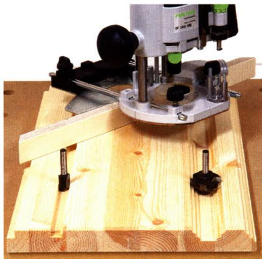
**Führungsschiene:** Im Gegensatz zum Parallelanschlag bietet sie eine freie Positionierung auf dem Werkstück und eine zwangsgeführte Oberfräse.
