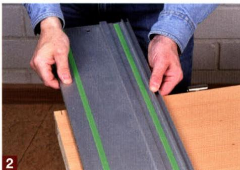
Richten Sie anschließend die Gummilippe der Führungsschiene auf diesen Strich und genau parallel zur Türunterkante aus. Fixieren Sie die Schiene mit den beiden Spezialzwingen auf der Tür. Stellen Sie die maximale Sägetiefe ein und sägen Sie den Überstand ab. Lassen Sie den Abschnitt möglichst nicht herunterfallen!
