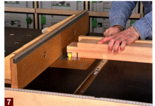
Anschließend spannen Sie Ihren größten Nutfräser ein und fräsen auf dem Frästisch mithilfe des Queranschlags den Zapfen an. Dabei nach und nach nur 6 – 8 mm Material wegnehmen, bis der Zapfen am Fräsanschlag anliegt.
