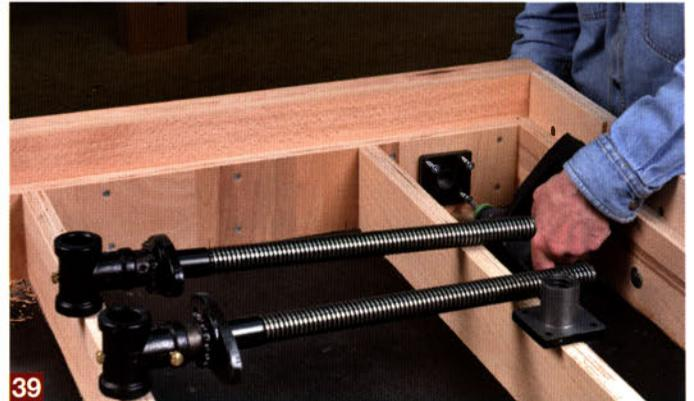
39 Die bei der Doppelzange mitgelieferten Gewindegegenlager werden mit Schrauben (unbedingt vorbohren!) an der Tischzarge festgeschraubt.
