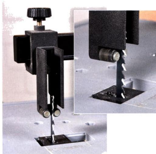
Das Sägeblattende wird zwischen zwei Rollen geführt, das minimiert tatsächlich wirkungsvoll das „Verlaufen“ des Sägeblatts. Befestigen Sie aber die Maschine so, dass vor allem geschränkte Sägeblattzähne immer vor den Rollen laufen, sonst werden Zähne und Rollen beschädigt! Zudem müssen Sie bei Werkstückdicken über 20 mm längere Stichsägeblätter einsetzen (ab 130 mm), sonst läuft das Ende nicht mehr zwischen den Rollen.
