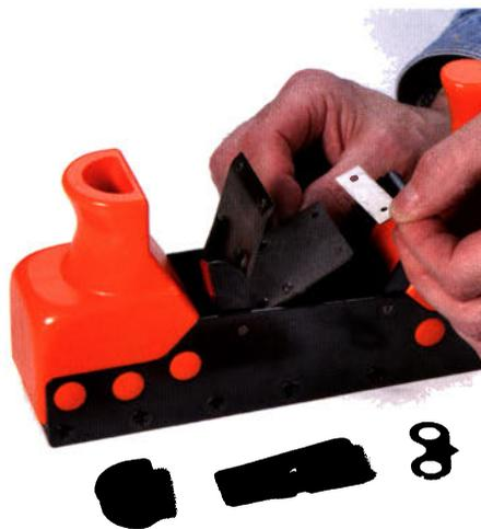
Das Wendemesser sitzt passgenau und formschlüssig (Stifte und Bohrungen) zwischen dem unteren Messerträger und dem oberen (verstellbaren!) Spanbrecher. Falls nötig kann außerdem noch die Öffnung des Hobelmauls durch Verschieben der vorderen Hobelsohle verstellt werden. Mit einem kleinen Hebel können Sie den Überstand der Schneide und somit die Spanabnahme ganz präzise einstellen. Dabei bleibt die Schneide immer parallel zur Hobelsohle.
