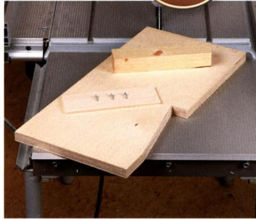
Für die Schablone benötigen Sie ein Holzbrett in der gleichen Stärke wie das Brett aus dem die Keile gesägt werden sollen. In die Längskante des Bretts die Form des Keils mit einer Stichsäge schneiden. Auf diese Ausklinkung ein Sperrholzbrettchen und einen weiteren Holzklötz als Handauflage zum Vorschieben der Schablone schrauben.
