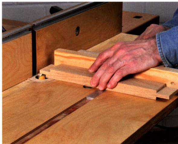
Der selbstgebaute Queranschlag besitzt im unteren Bereich ein Flachprofil aus Aluminium, das in einer entsprechenden Nut in der Tischfläche absolut spielfrei hin und her läuft. Zudem kann der Anschlag auch stufenlos schräg gestellt werden, damit auch Leisten mit einem bestimmten Winkel an den Queranschlag gelegt werden können.
