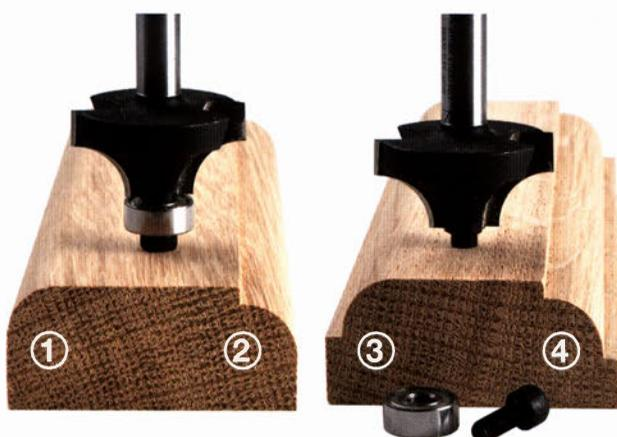
Mit einem Abrundfräser samt Kugellager können Sie neben einer einfachen Rundung (1) durch Verändern der Frästiefe auch eine Kante bzw. einen Absatz fräsen (2). Wenn Sie jedoch das Kugellager entfernen, können Sie zusätzlich zu den beiden linken Profilen noch einen Absatz in die Holzkante einfräsen (3) + (4).
