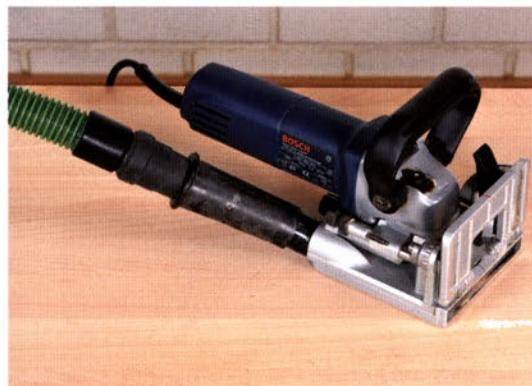
Ein flexibler Adapter aus weichem Gummi ist oft die letzte Rettung, wenn der Saugschlauch nicht direkt auf den Absaugstutzen des Elektrowerkzeugs passt.
