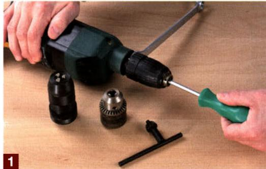
Danach drehen Sie das Bohrfutter mithilfe einer Rohrzange ab (zum Schutz ein Tuch zwischenlegen). Hier handelt es sich um ein normales Rechtsgewinde (zum Öffnen nach links drehen).
