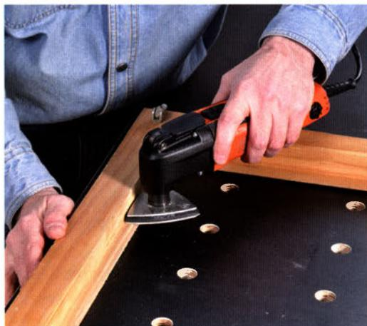
Der Dreieckschleifer ist die ideale Ergänzung zum Exzenterschleifer, der aufgrund seines runden Schleiftellers keine Ecken bearbeiten kann. Und genau hier ist der dreieckige Schleifteller dieser leichten und handlichen Maschine ganz in seinem Element. Ob Sie nun die Ecken eines Schubkastens, den Falz einer Tür oder mit dem passenden Zubehörschuh die Lamellen eines Fensterladens schleifen möchten, der Dreieckschleifer ist genau die richtige Maschine dafür.
