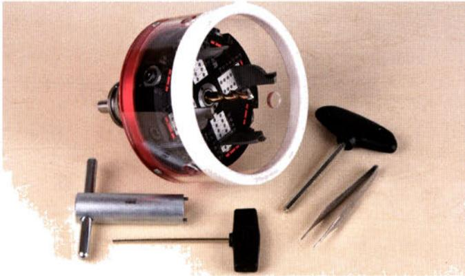
Der Kreisschneider der Fa. Protool bohrt Löcher von 50 – 120 mm Durchmesser, wobei die Schneiden und somit der Durchmesser in 0,2 mm (!!!) Schritten präzise und wiederholgenau eingestellt werden können. Zwei Schneiden dienen als Vorritzer und stehen etwas weiter vor als die beiden Hauptschneiden. Dadurch sind absolut ausrissfreie Bohrlöcher garantiert. Ein beeindruckendes Präzisionsinstrument, das aber auch seinen Preis hat.
