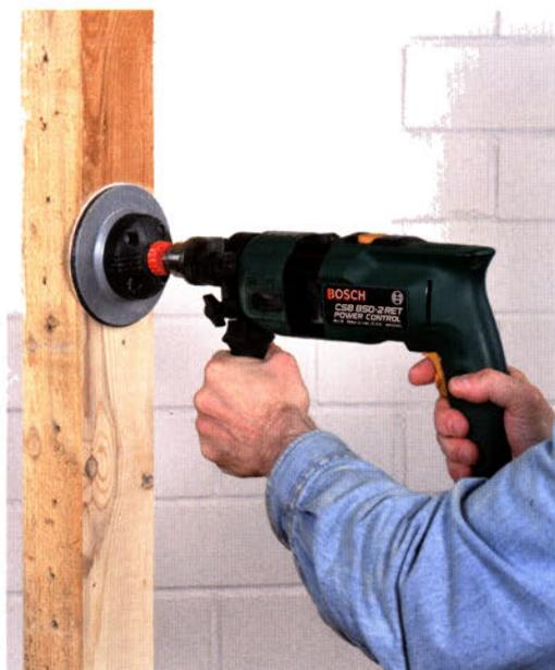
Eine kraftvolle und solide Schlagbohrmaschine gehört immer noch in jede Holzwerkstatt. Auch wenn der Akku-Bohrschrauber in vielen Fällen die handlichere Alternative ist, stößt er doch leistungsmäßig schnell an seine Grenzen. Genau dann macht sich eine leistungsstarke Schlagbohrmaschine schnell bezahlt.
