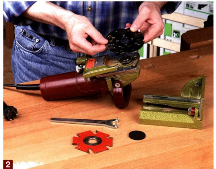
**2** „So wie ich lauf – so geh ich auf“. Zum Öffnen der Befestigungsmutter muss der Schlüssel einfach in die Richtung der Fräserzähne gedreht werden.
