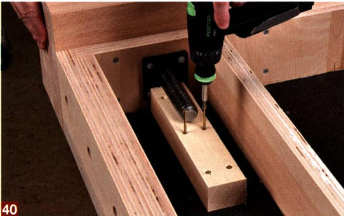
40 Ein Holzklötz, dicht unter die beiden Spindeln geschraubt, verhindert, dass die Spannzange aufgrund des hohen Gewichts später nach vorne abkippen kann.
