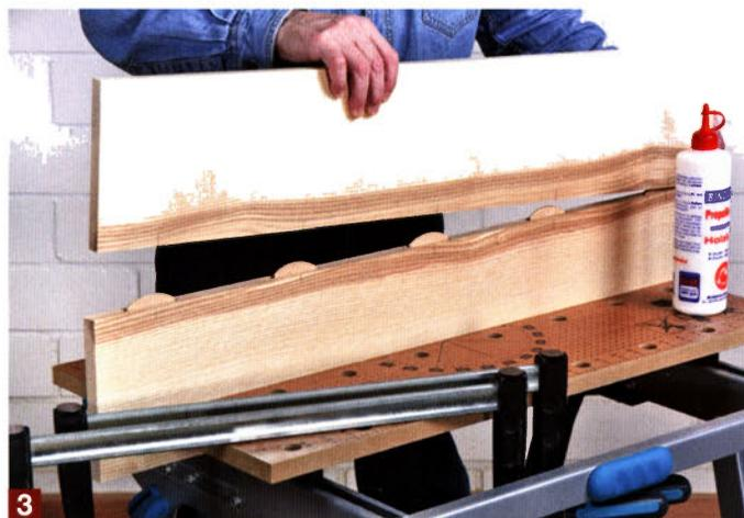
3 Bevor Sie Leim aufgeben, testen Sie zuerst immer die Passgenauigkeit der Verbindung ohne Leim. Danach geben Sie Leim sowohl in die Flachdübelschlitzlöcher als auch auf die Holzkanten auf.
