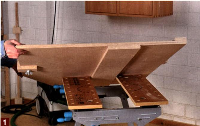
1 Das Zuschnittbrett kann entweder auf Holzböcken fixiert werden, oder – falls vorhanden – auf einem Spanntisch oder einer Hobelbank. Dazu wird einfach der rückseitig verschraubte Plattenstreifen in die Spannbacken eingeklemmt.
