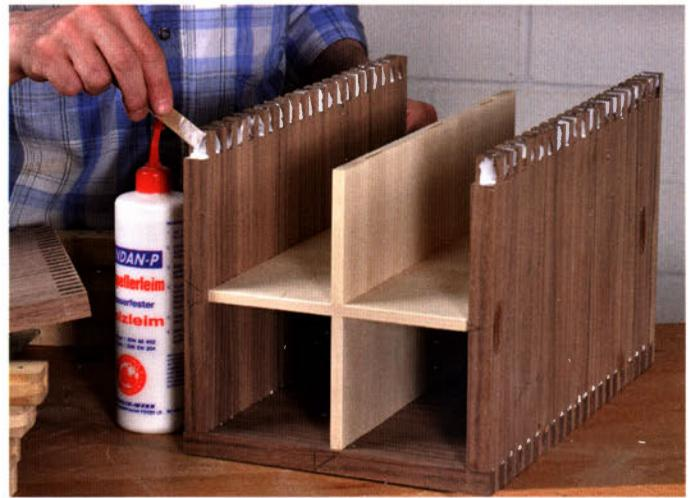
Bei Zinken- und Zapfenverbindungen geben Sie den Leim zunächst mit der Dosierspitze zwischen die Zinken und verteilen ihn dann mit einem dünnen Holzstreifen.
