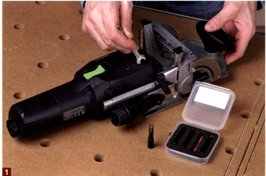
**1** Heben Sie mit dem Maulschlüssel den Entriegelungs-Hebel bis zum hörbaren Entrasten des Anschlags an. Jetzt können Sie Motoreinheit und Anschlag voneinander trennen.
