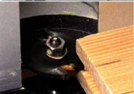
Zur Aufnahme der Füllung fräsen Sie mit einem Scheibennutfräser in die Rahmenteile (Pos. 1, 2 und 3) eine 12 mm tiefe und 8 mm breite Nut.
