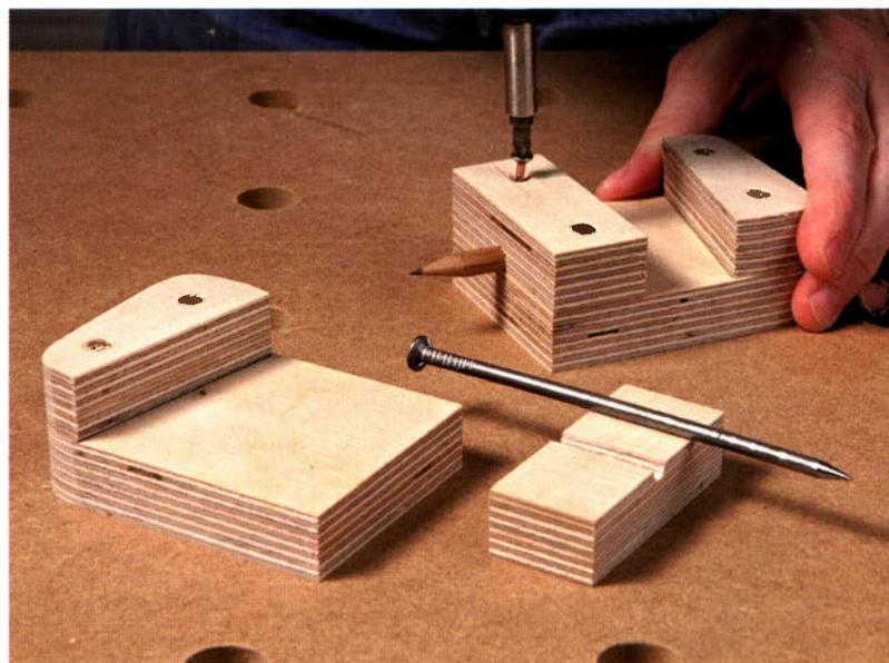
Mit Handsäge und Stechbeitel zwei Schlitz für Nagel und Bleistift in die unteren Klötzchen so tief einarbeiten, dass Sie nach dem Aufschrauben fest eingeklemmt sind.
