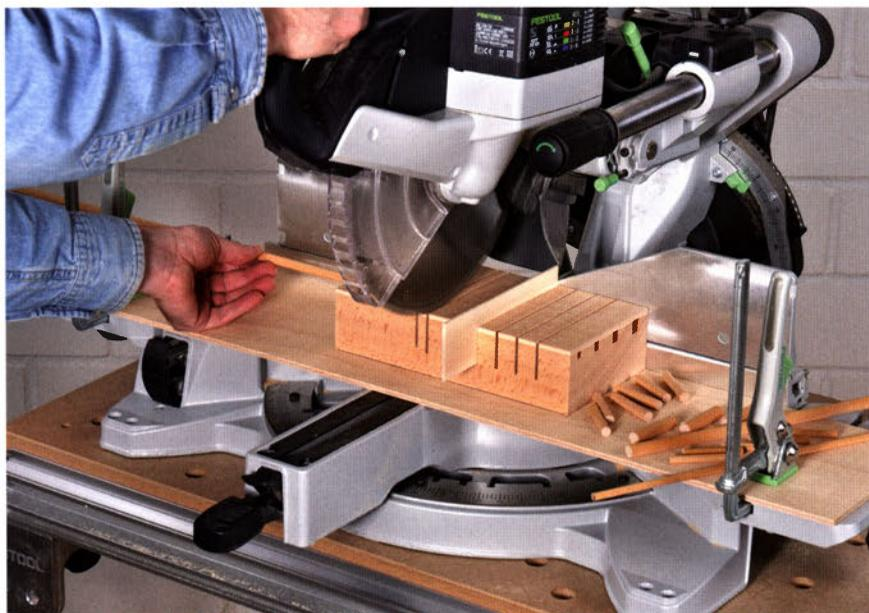
So einfach gehts: Dübelbox zum Sägeblattschlitz ausrichten und mit zwei Hebelzwingen befestigen. Schieber in den gewünschten Schlitz stecken und Dübel ablängen.
