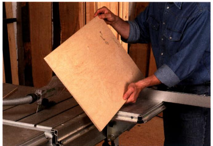
Sägen Sie einen 5–10 mm breiten Streifen von einer der langen Plattenkanten ab. Drehen Sie die Platte um und sägen Sie von der gegenüberliegenden Plattenkante ebenfalls einen Streifen ab.
