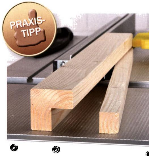
Große, üppige Falztiefen lassen sich auf der Tischkreissäge schneller und sicherer herstellen als auf der Tischfräse oder einem Frästisch. Zudem spart man erheblich an Material, da die abfallende Leiste, die sonst im Sauger landet, noch weiter genutzt werden kann.
