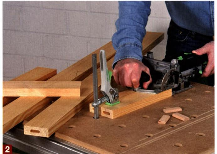
2 Da die Dominos mit etwas „Spiel“ (mittlere Schalterstufe) eingefräst werden, können Sie die Markierungen bequem und einfach über die Mittenskala im umgeklappten Anschlag ablesen.
