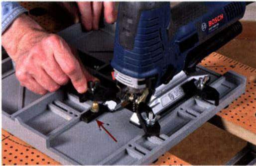
Durch die gerippte Kunststoffplatte ist die Maschine sofort parallel zur Platte ausgerichtet. Über einen kleinen verstellbaren Anschlag (Pfeil) lässt sich der Abstand innerhalb der Sägeblattöffnung justieren.
