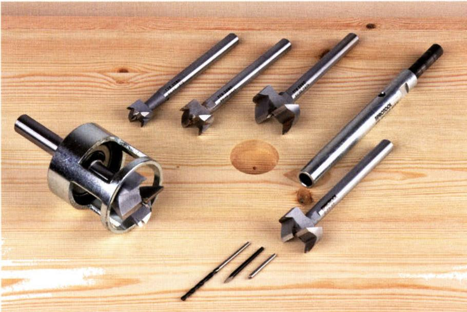
Die Kunstbohrer des ZOBO Bohrsystems von der Fa. Protool lassen sich durch unterschiedlich lange Zentrierspitzen, Schaftverlängerungen und aufsteckbare, kugelgelagerte Tiefenstopps sinnvoll ergänzen und der jeweiligen Anwendung optimal anpassen. Die Bohrer sind wahlweise in Chromstahl oder mit Hartmetall bestückten Schneiden in 1 mm Stufen von 10 – 130 mm (ZOBO 3) erhältlich. Diese Vielseitigkeit und Qualität hat allerdings auch ihren Preis.
