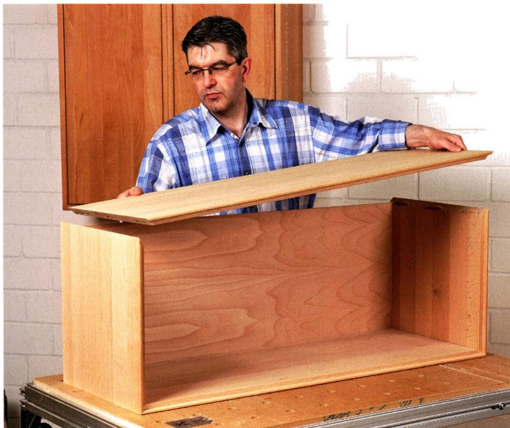
Besonders bei Gehrungen sollten Sie zuerst immer einen Testversuch ohne Leim starten. Dabei auch die Zulagen, Spanngurte und/oder Zwingen ansetzen. So können Sie auch gleich kontrollieren, ob die Verbindungen alle passen und „dicht“ werden.
