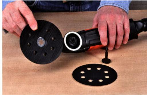
Der runde Schleifteller hat einen Durchmesser von 115 mm und ist mit 8 Absauglöchern versehen. Dafür passende Schleifpapiere mit Klett- haftung finden Sie in jedem gut sortierten Werkzeughandel. Viele Exzentrerschleifer mit 115 mm Teller haben das gleiche Lochbild.
