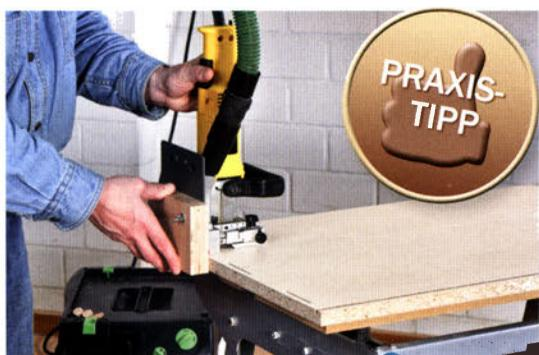
Dieser Überstand liegt dann an der Plattenkante an, während die Frontplatte auf der Plattenfläche aufliegt. Ein Kippen ...
