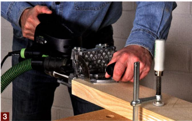
... versenkt). Anschließend den Anschlagstift einfach links gegen das zuvor gefräste Loch anschlagen und mit diesem festen Rasterabstand das zweite Loch fräsen.
