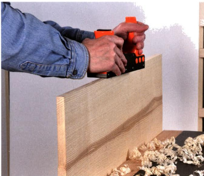
Die Sägespuren eines mit der Kreissäge zugeschnittenen Bretts, können Sie mit wenigen Hobelzügen entfernen. Mit ein wenig Übung können Sie auf diese Weise eine extrem glatte und schnurgerade Kante erzeugen, die Sie mit einem Schleifgrät so nicht erreichen. Schleifmaschinen – egal welcher Art – hinterlassen meistens kleine Dellen oder je nach Führung auch leicht schrägverlaufende Brettanten.
