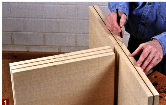
Zunächst werden alle Bauteile mit dem sogenannten Schreinerdreieck versehen. So verliert man beim Fräsen nicht so schnell den Überblick.
