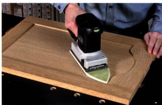
Durch Lösen von vier Schrauben lässt sich der rechteckige Schleifschuh gegen einen optionalen Spezialschleifschuh mit dreieckiger Spitze tauschen. Damit können Sie dann auch in Ecken und schwer zugänglichen Stellen schleifen.
