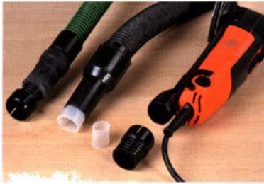
Achten Sie beim Kauf auch darauf, dass Sie zum Schleifen eine zusätzliche Staubabsaugung anschließen können. Auch die passenden Adapter für Ihren Saugschlauch sollte der Hersteller gleich mitliefern.
