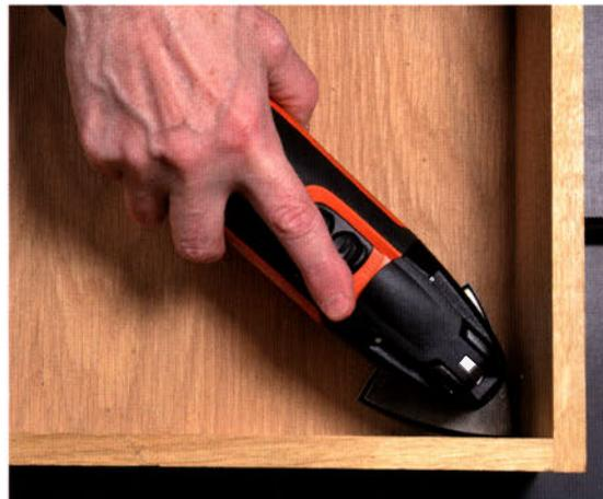
Durch die geringe – aber dennoch kraftvolle – Schwingbewegung des Schleiftellers, können Sie problemlos bis dicht an den Rand und in die Ecken eines Fensterfalz schleifen, ohne auch nur das geringste „Anschlagen“ des Tellers zu spüren.
