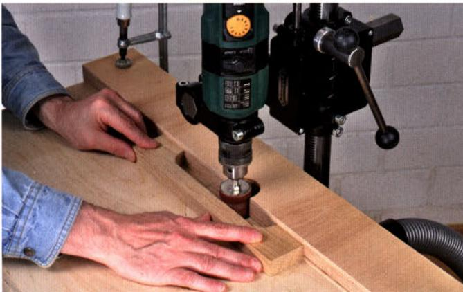
Spannen Sie eine gerade Anschlagleiste, die in der Kantenmitte eine Ausklinkung passend zur Schleifhülse hat, mit Zwingen auf der Schleifstation fest. Stellen Sie über ...
