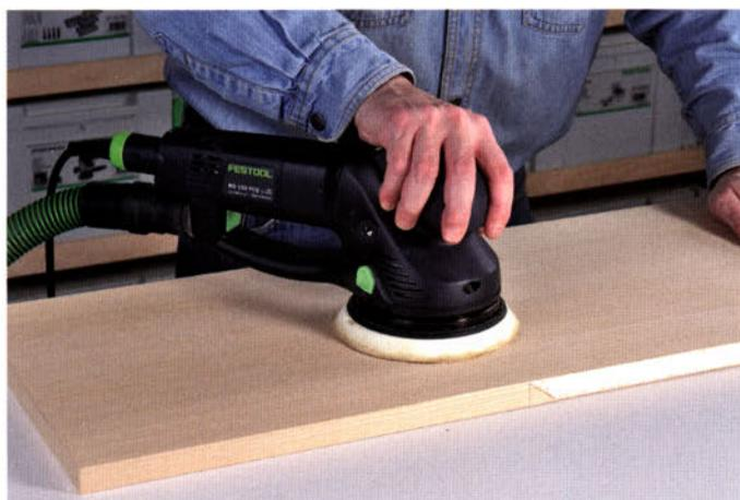
Durch das nach hinten ragende Motorgehäuse liegt der Schwerpunkt nicht in der Mitte der Schleiftellerfläche – die Maschine neigt immer etwas zum rückseitigen Abkippen. Das satte Aufliegen des Tellers beim Schleifen mit nur einer Hand, wie es beim normalen Exzentrerschleifer der Fall ist, lässt sich mit diesem Schleifer nicht erreichen.
