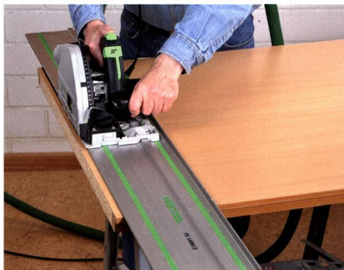
Bei der Verlegung von Parkett oder Laminat muss in den meisten Fällen auch die Zimmertür gekürzt werden. Mit einer Tauchsäge und der passenden Führungsschiene, ist das Ganze ein Kinderspiel und gelingt auch dem weniger geübten Holzwerker auf Anhieb.
