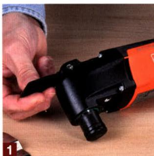
1 Spannhebel öffnen
