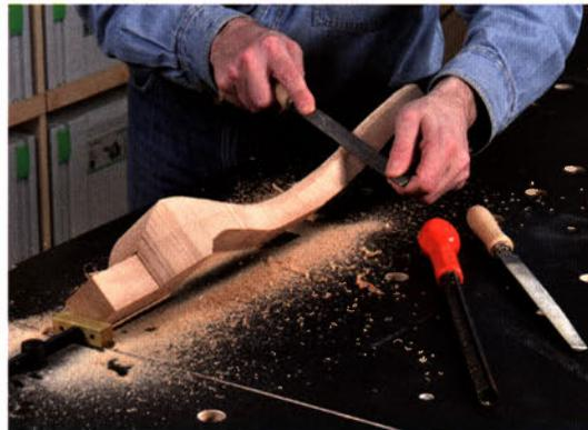
Mit Harz und Holzspänen verklebte Raspeln und Feilen können Sie zunächst in heißem Wasser einweichen (Griff nicht ins Wasser legen!). Dadurch quellen die Holzteilchen und können anschließend mit einer Wurzel- oder Stahlbürste ganz leicht entfernt werden.
