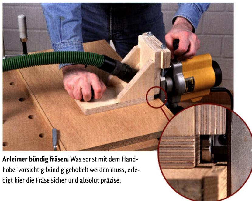
**Anleimer bündig fräsen:** Was sonst mit dem Handhobel vorsichtig bündig gehobelt werden muss, erledigt hier die Fräse sicher und absolut präzise.
