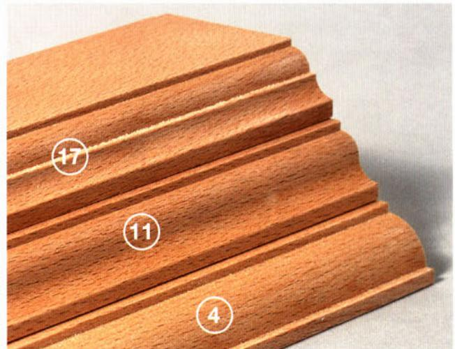
In dem Sie mehrere profilierte Bretter zusammenleimen oder notfalls auch schrauben, können Sie im Handumdrehen weit ausladende und groß dimensionierte Kranz- oder Sockelprofile herstellen. Das linke 40 mm hohe Profil wurde beispielsweise aus den beiden Profilen Nr. 14 und 19 zusammengesetzt. Das 60 mm hohe rechte Profil besteht aus drei 20 mm dicken profilierten Leisten.
