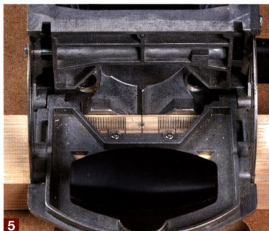
... genau senkrecht von oben (nicht seitlich!) durch das Klarsichtfenster der Dominofräse anvisieren. Nur so ist ein präzises Ergebnis gewährleistet.
