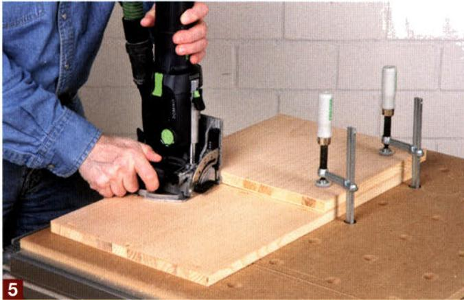
5 Bei einer T-Verbindung (hier der Zwischenboden) spannen Sie den Boden fest auf die Seitenwand und benutzen seine Kante als Anschlag für die Dominofräse. Fräsen Sie dann zunächst mit der hochkant stehenden Fräse die Schlitzlöcher in die Seitenwand.
