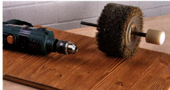
Anstelle teurer Spezialmaschinen können Sie auch mit der Bohrmaschine und einer solchen Messingbürste Holzoberflächen strukturieren. Dabei werden die weichen Frühholztonen abgetragen und die härteren Spätholztonen treten so hervor.
