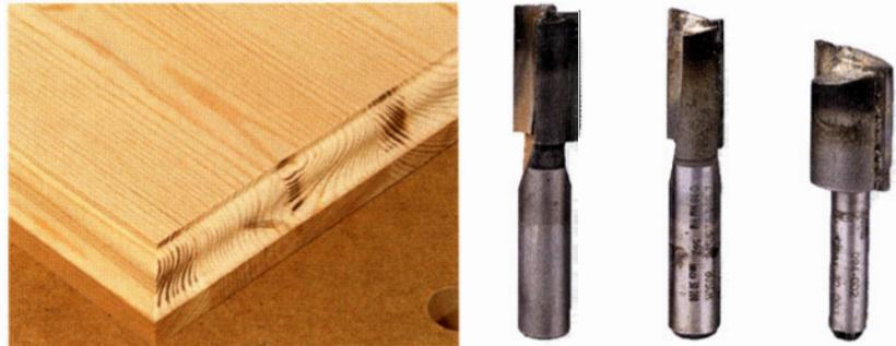
Wird die Fräse zu langsam geführt, entstehen vor allem im Stirnholzbereich dunkle Brandspuren, die nur sehr mühsam entfernt werden können (li.). Dabei leiden aber auch die Fräuserschneiden. Sie überhitzen und werden sehr schnell stumpf. Sind sie dabei auch noch dunkel angelaufen, lohnt auch ein Nachschärfen nicht mehr (re.).
