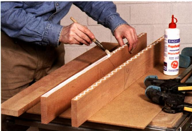
Bei der Leimholzherstellung wird zunächst mit der Dosierspitze Leim auf die Kante gespritzt und anschließend mit einem Leimpinsel gleichmäßig auf der Kante verteilt.
