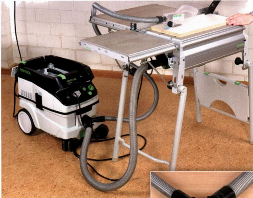
Bei Tischkreissägen und Frästmischen sollten Staub und Späne sowohl ober- als auch unterhalb des Werkstücks abgesaugt werden. Dazu gibt es im Zubehör passende Y-förmige Verteilerstücke, die direkt in den Schlauchstutzen des Saugers gesteckt werden.
