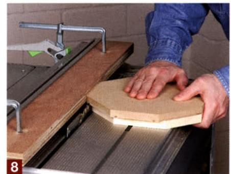
Um kleinere Werkstücke als die Schablone herzustellen, müssen Sie nur den Parallelanschlag samt Führungsleiste vom Sägeblatt wegschieben. Der Abstand zwischen Führungsleiste und Außenseite des Sägeblatts bestimmt dabei den Wert der Verkleinerung. Bei einer Vergrößerung des Werkstücks wird die Führungsleiste einfach weiter über das Sägeblatt heraus bewegt. So lassen sich – ohne weitere Schablonen anfertigen zu müssen – Vergrößerungen bzw. Verkleinerungen bis ca. 6 cm herstellen.
