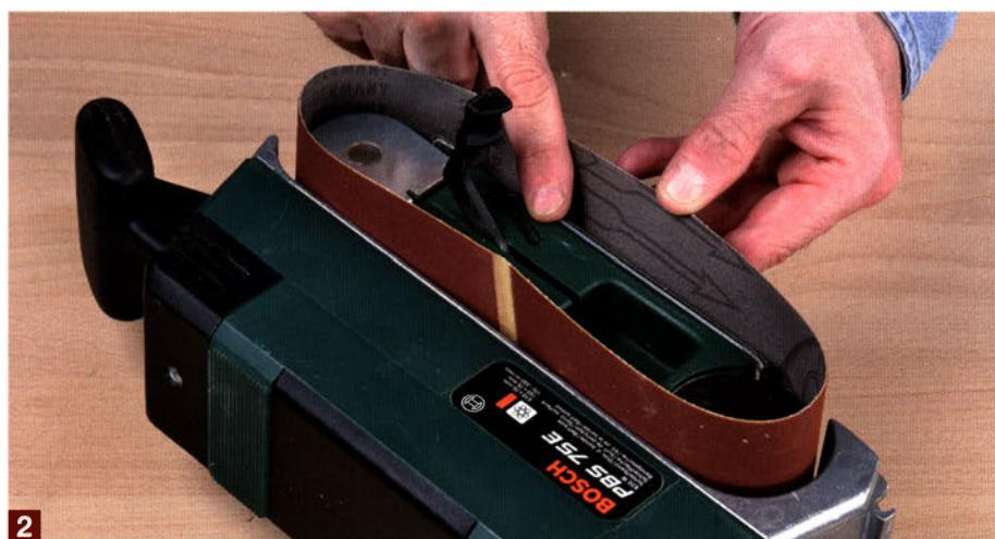
Stecken Sie das neue Schleifband so über die beiden Rollen, dass der Pfeil auf dem Schleifband in dieselbe Richtung zeigt wie der auf der Maschine. Dann den Spannhebel wieder ganz in das Gehäuse einklappen.
