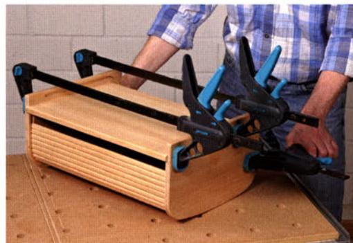
Besonders beliebt sind diese handlichen und leichten Einhandzwingen. Der Pressdruck reicht für die meisten Arbeiten völlig aus und durch die Schutzbacken benötigen Sie keine Unterlagen.
