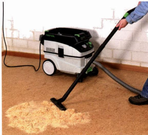
Ein leistungsfähiger Werkstattsauger schützt nicht nur Ihre Gesundheit, sondern verlängert auch deutlich die Lebensdauer Ihrer Maschinen. Denn wenn Staub und Späne bereits zuverlässig am Elektrowerkzeug abgesaugt werden, können sie nicht mehr die Maschine verschmutzen und sich im Motor oder auf den Kontakten festsetzen.
