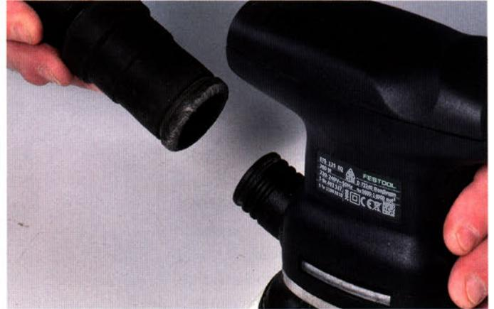
Achten Sie beim Kauf von Sauger oder Maschine auch auf den passgenauen Sitz des Saugschlauches. Der Stutzen sollte so flexibel sein, dass er schön fest auf der Maschine sitzt und nicht gleich beim ersten Gebrauch abfällt.
