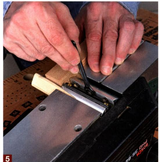
Richten Sie das Ende des Messers mit einem Holzklötzchen genau zur Hobelsohle aus und fixieren Sie den Messerträger wieder in der Welle, indem Sie zuerst die mittlere Schraube und danach erst die beiden äußeren Schrauben anziehen.
