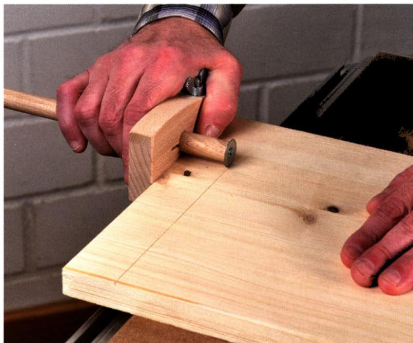
Fein durchtrennte Holzfasern erhalten Sie mit dem zweiten Streichmaßmodell. Eine an den Kanten spitz angeschärfte Unterlegscheibe fungiert hier als Messer und wenn eine Stelle nach längerem Gebrauch stumpf geworden ist, wird die aufgeschraubte Scheibe einfach etwas verdreht.
