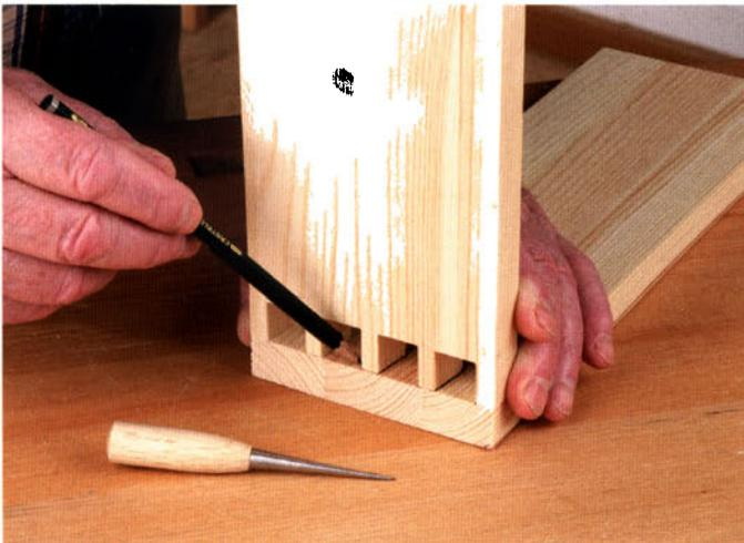
Ein „scharf“ gespitzter harter Qualitätsbleistift ist beim Übertragen der Schwalben oftmals die bessere Lösung. Gut sichtbare Linien bei minimalem Druck.
