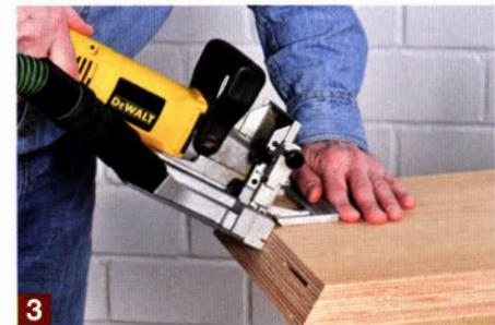
Am Schwenkanschlag können alle Winkel von 0° – 90° stufenlos eingestellt werden. So können Sie die Maschine auch problemlos und sicher an schrägen Werkstückkanten anlegen.
