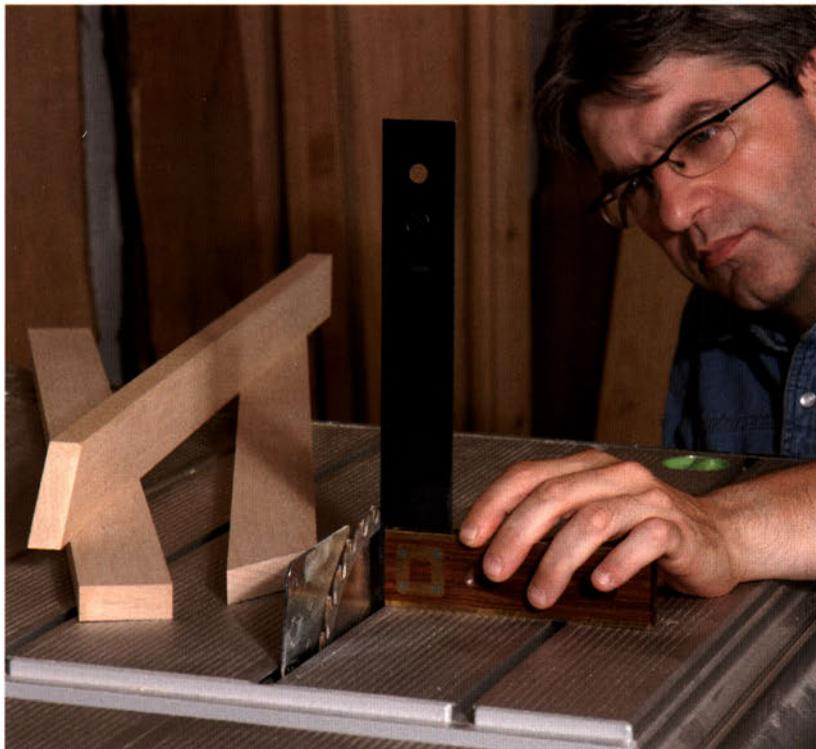
Damit die Tischkreissäge auch genau rechtwinklige Zuschnitte produziert, muss das Sägeblatt erstens rechtwinklig zur Tischfläche und zweitens rechtwinklig zum Winkelanschlag oder Schiebetisch eingestellt sein.
