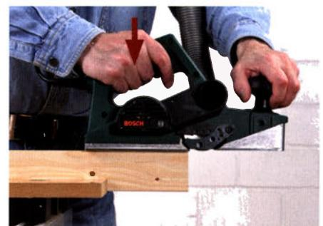
Zum Ende des Werkstücks hin den Druck nur noch auf die hintere Sohle verlagern.
