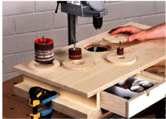
Die Schleifstation wird einfach auf der Tischfläche des Bohrständers mit zwei Zwingen befestigt. Sie hat daher auch genau die gleiche Plattengröße. So ist sie jederzeit in Sekundenschnelle einsatzbereit.
