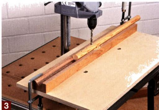
**3** Müssen die Löcher flach in den Rundstab gebohrt werden, hilft eine solche Leiste, die auf der Tischkreissäge V-förmig genutet wurde. In der V-Nut liegt der Rundstab relativ verdrehsicher.
