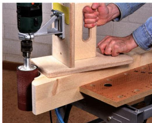
Auch mit selbstgebaute Vorrichtungen können Sie kostengünstig das Einsatzspektrum einer Bohrmaschine erweitern, wie z. B. bei dieser mobilen Kantenschleifvorrichtung.
