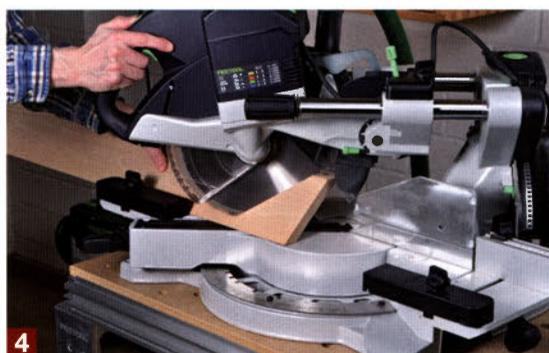
... horizontal in den gewünschten Winkel geschwenkt. Dann das Sägeblatt nach vorne ziehen, einschalten und ins Werkstück eintauchen, danach das laufende Sägeblatt zurückschieben.
