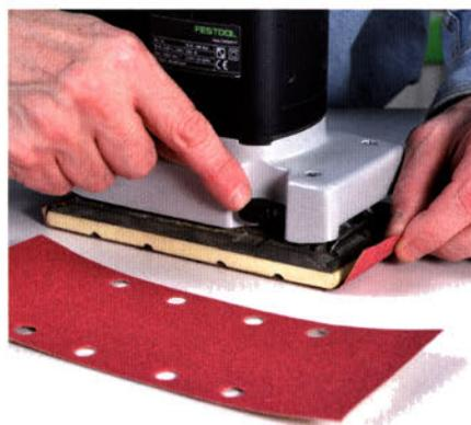
Günstiger sind fertig gelochte Schleifbögen ohne Velourbelag, deren Enden unter den beiden Klemmleisten fixiert werden. Allerdings ist der Wechsel deutlich umständlicher.
