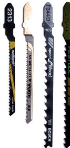
Kurvensägeblätter gibt es in einer kurzen und schmalen Ausführung, mit vielen Zähnen für enge Radien auch in sehr dünnem Material oder die etwas längeren und breiteren für Materialstärken von ca. 10 bis maximal 50 mm.
