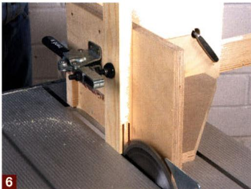
6 Um den passenden Zapfen zu sägen muss der Abstand der Vorrichtung zum Sägeblatt neu eingestellt und mit ein paar Probehölzern überprüft werden.
