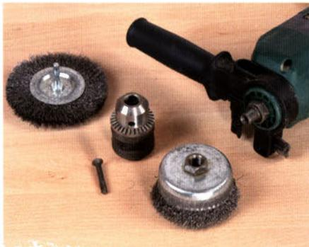
Zum Entfernen von Farbe und Rost (z. B. beim Gartentor aus Metall) gibt es zahlreiche Bürstentypen. Einige Topfbürsten werden dazu nach Abnahme des Bohrfutters direkt an die Maschinen geschraubt.
