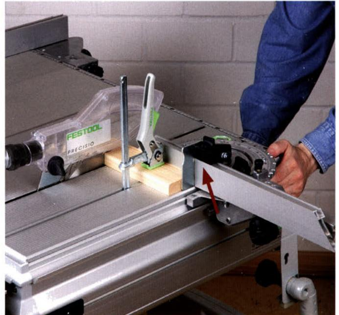
Setzen Sie die Hebelzwinde so oft wie möglich ein, vor allen Dingen aber beim Ablängen von kurzen Werkstücken. So sind die Hände geschützt und das Werkstück kann unmöglich verrutschen. Ein Anschlagreiter (Pfeil) garantiert dabei immer gleich lange Werkstücke.
