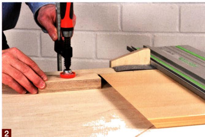
2 Erst wenn alle Platten mit einer Gehrungskante versehen wurden, stellen Sie mithilfe eines Anschlagklötzchens die gewünschte Plattenlänge ein und legen die zuvor gesägte Gehrung gegen den Anschlag.
