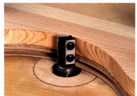
... absolut gefahrlos am Fräser vorbei führen. Bei dieser Anwendung muss sich die Schablone allerdings unter dem Werkstück befinden. Deshalb können nur Fräser eingesetzt werden, bei denen sich das Kugellager am Schaft befindet.
