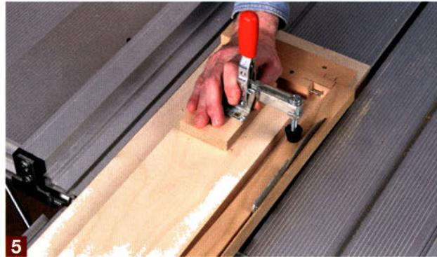
Für den ersten Schrägschnitt legen Sie das Pfostenende in die obere Aussparung an den Schraubenkopf. Um die gegenüberliegende Fläche ebenfalls anzuschragen, drehen Sie den Pfosten um 180° und legen die soeben gesägte Fläche einfach gegen die Aussparung unterhalb der Schraube (Pfeil).
