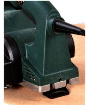
Der bewegliche Parkschuh verhindert, dass das auslaufende Hobelmesser beim Absetzen der Maschine etwas beschädigen kann. Achten Sie beim Abstellen auf einer Tischfläche immer darauf, dass der Parkschuh nicht über die Tischkante hinausragt.
