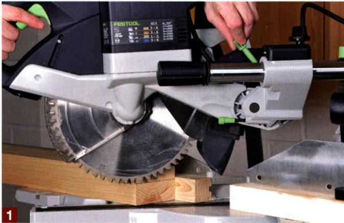
Zuerst wird die Dicke des Werkstücks, das in den Balken eingelassen werden soll, am Balkenende markiert. Anschließend wird durch Drehen des Kapptiefen-Hebels die Schnitttiefe eingestellt.
