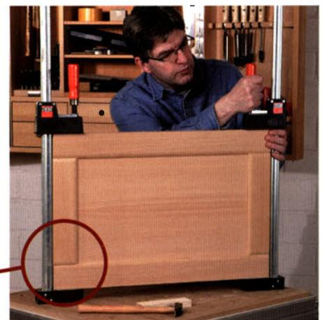
Aber auch mit einer einfachen glatten Sperrholzfüllung, die in die 5 mm Nut gesteckt wird, macht der Rahmen ein gute Figur.
