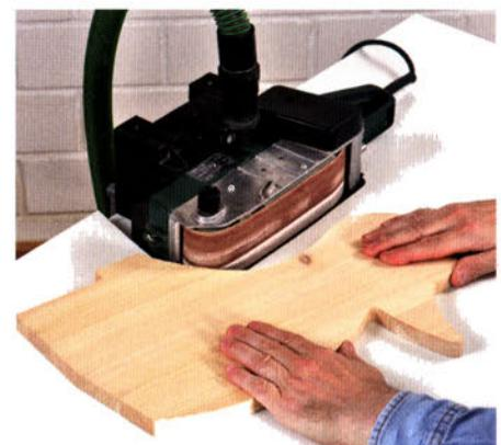
Ein passender Winkelanschlag ist ideal, wenn die Kanten größerer Werkstücke geschliffen werden sollen (oben). Auf die Seite gelegt und fixiert, wird aus dem Bandschleifer im Nu eine stationäre Kantenschleifmaschine (unten).
