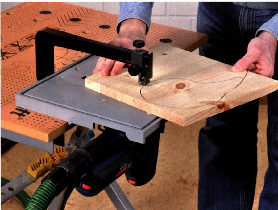
Ein Stichsäge Tisch hat den großen Vorteil, dass Sie den Schnittverlauf besser kontrollieren können. Die Sicht auf die Bleistiftlinie wird nicht wie sonst üblich durch die Maschine behindert.
