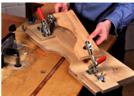
Besonders komfortabel sind Schablonen mit Schnellklemmen. Hier werden die Werkstücke einfach in die Schablone eingelegt und mit den beiden Klemmen fixiert. Ist die Schablone dann noch mit zwei einstellbaren Anschlagbrettchen ...
