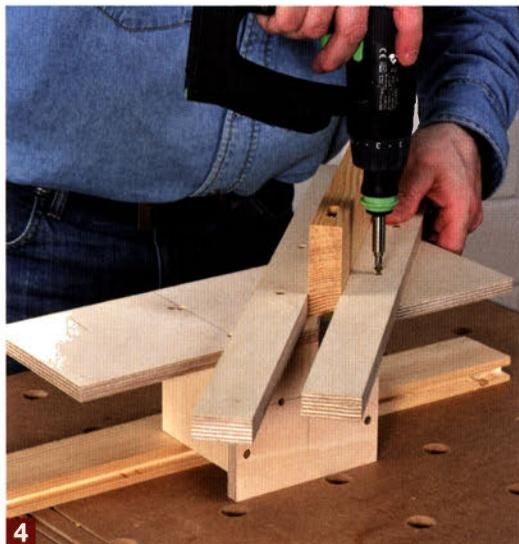
7 mm von der Mittellinie der Vorrichtung entfernt eine Markierung machen und zuerst die linke Führungsleiste 45° schräg unter die Grundplatte festschrauben (achten Sie auf die Position des Metallplättchens!).
