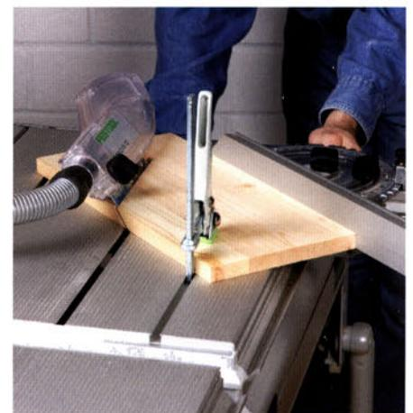
Ein präziser Zuschnitt einer Doppelgehrung ist immer eine Herausforderung. Dabei muss sowohl das Sägeblatt, als auch der Anschlag geschwenkt werden.
