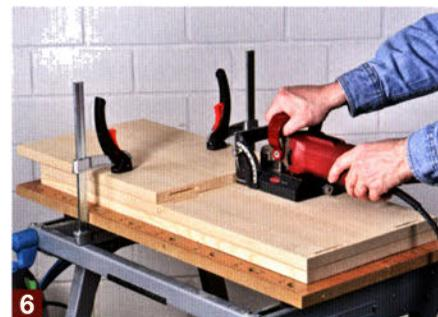
Dann die Maschine flach auf die Seitenwand legen und in die Stirnkante des Zwischenbodens ebenfalls zwei passende Gegenschlitz fräsen.
