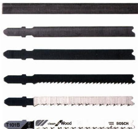
1. Bandstahl als Ausgangsmaterial
