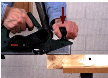
Setzen Sie den Hobel mit der vorderen Sohle auf das Werkstück, üben Sie nur dort Druck aus!
