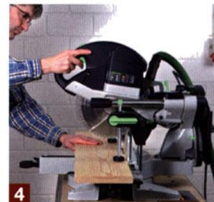
4 Sägeaggregat hochschwenken und erst danach ausschalten
