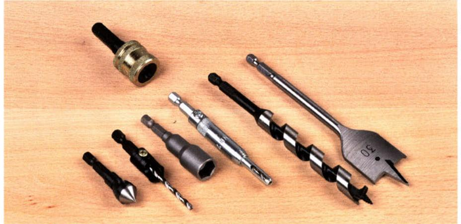
Es gibt für fast jede Anwendung ein Snappy-Werkzeug. Alle haben eines gemeinsam, die spezielle sechskantige Snappy-Aufnahme. Stecken Sie auf keinen Fall Sechskantaufnahmen eines anderen Herstellers in den Adapter!
