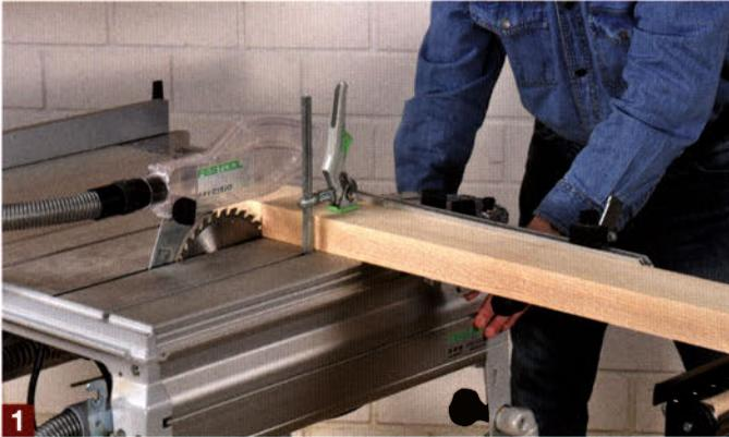
**1** Nach dem Aushobeln der Eschenbohlen werden zuerst alle Blendrahmenteile genau auf Länge zugeschnitten.
