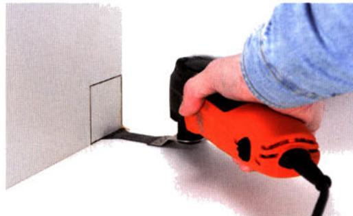
Bei gekröpften Sägeblättern sitzt die Spannschraube zurückgesetzt in der Kröpfung. Dadurch kann das Sägeblatt bündig zur Werkstückoberfläche angesetzt werden. Um Beschädigungen an benachbarten Flächen zu vermeiden können Sie Karton unterlegen.
