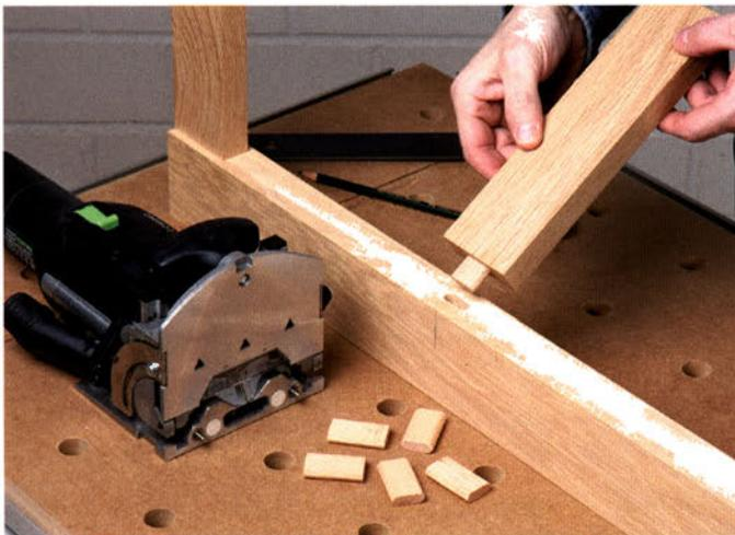
Anschließend wird das Gegenstück gefräst, und nachdem der passende Domino in den Schlitz gesteckt wurde, passen beide Holzteile perfekt zusammen.
