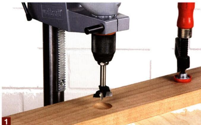
**1** Um eine Kugel genau mittig aufzubohren, wird zuerst mit einem Forstnerbohrer ein großes Loch in ein Holzbrett gebohrt. Anschließend wird der Forstnerbohrer entfernt ....
