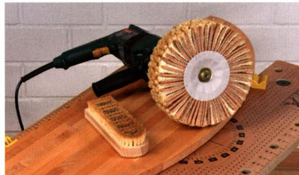
Mit Fächerscheiben einer Sisalkordel-Lederbürste (Fa. Picard) können Sie völlig mühelos mit der Bohrmaschine gewachste Holzoberflächen polieren. Für gelegentliche Polierarbeiten gibt es auch eine passende Handbürste.
