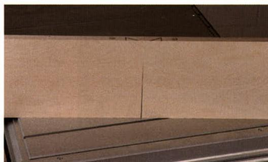
Werden die Schnittkanten anschließend zusammengestoßen, lassen sich Toleranzen sofort erkennen und leicht korrigieren.
