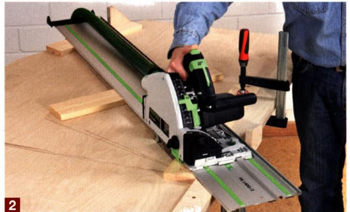
Dazu sägen Sie zunächst nur an jeweils ein Leistenende eine 45°-Gehrung an. Ein Brett oder eine Leiste gleicher Stärke als Unterlage in der Mitte der Säge-schiene sorgt dafür, dass die Schiene nicht zu sehr durchhängt.
