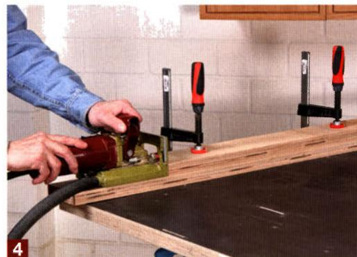
Um die Gegenschlitz für die Mittelzargen in die beiden seitlichen Zargen zu fräsen, spannen Sie die Zargen so aufeinander, dass die obere als Anschlag für die Maschine dient. Dann zuerst die Maschine wieder hochkant anlegen (3) und den Schlitz fräsen und erst danach die Maschine flach auflegen und in die Stirnkante einen Schlitz fräsen (4).
