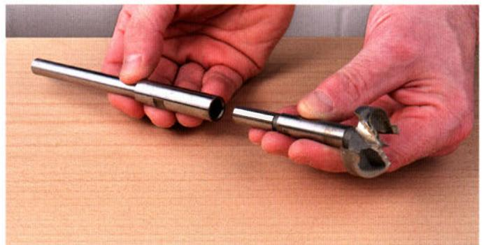
Die MaxiCut® Forstnerbohrer der Fa. Colt besitzen einen speziellen leicht wellenförmigen Schaft (ROTASTOP®). In der Verlängerung sitzt das passende Gegenprofil, sodass beide Teile nur ineinander gesteckt werden müssen und keine zusätzliche Befestigung mehr nötig ist. Durch diesen Spezialschaft kann der Bohrer auch nicht mehr im Bohrfutter "durchrutschen".
