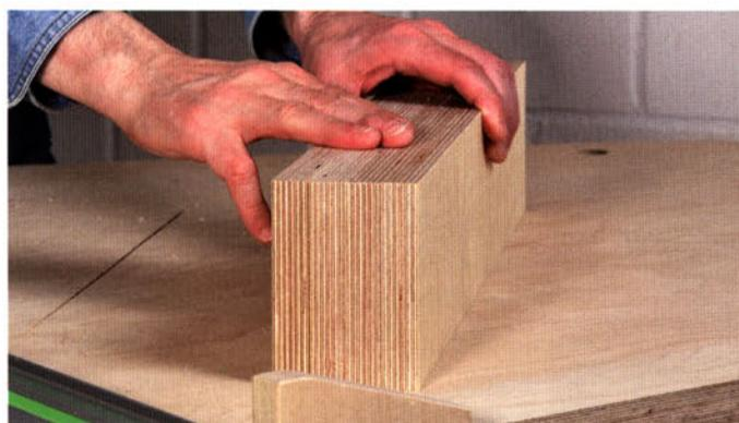
Wenn alle vier Schubkastenseiten zusammengelegt eine glatte Fläche ergeben, ist eine perfekte Wiederholgenauigkeit erreicht, das lässt sich mit einem Meterstab nicht kontrollieren.
