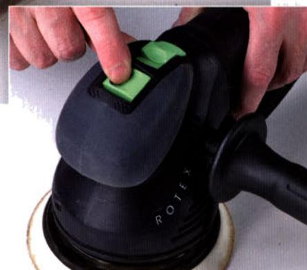
Mit einem Schalter können Sie die Maschine auf Grob- oder Feinschliff einstellen. Für den Grobschliff oder zum Polieren wird ein Getriebe zugeschaltet, mit dem sehr hohe Abtragsleistungen erreicht werden.
