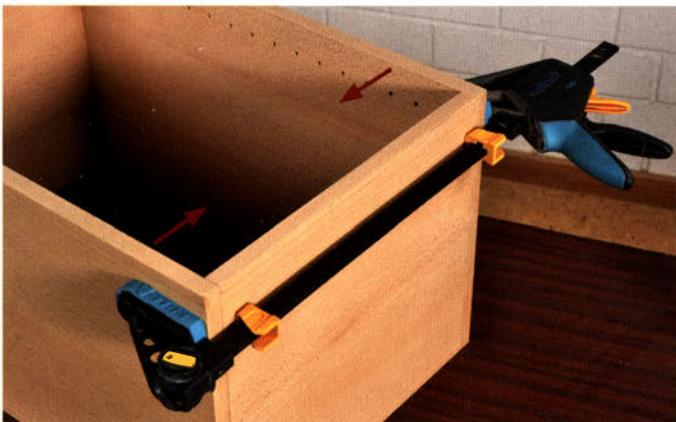
Falsche Position: So drücken die Backen die Seitenwände nach innen und es ergibt sich eine offene Fuge im Außenbereich des Bodens.
