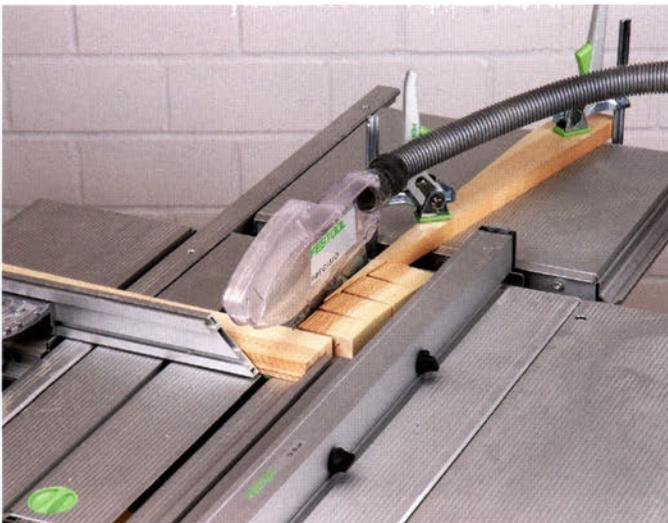
Die auf den hinteren Teil des Sägeblatts spitz zulaufende Abweisleiste verhindert, dass abgesägte Holzklötzchen von den hinteren aufsteigenden Sägeblattzähnen erfasst und gegen den Anwender geschleudert werden. Bevor Sie die Abweisleiste festspannen, ...
