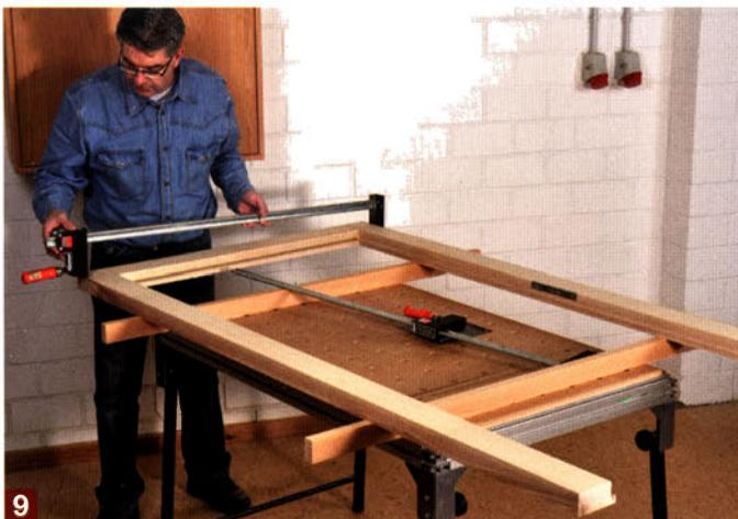
Erst wenn die Dichtungsnut gesägt und das Schließblech eingelassen wurde, sollten Sie den gesamten Blendrahmen mit den 140 mm langen und 14 mm dicken Dominodübeln verleimen.
