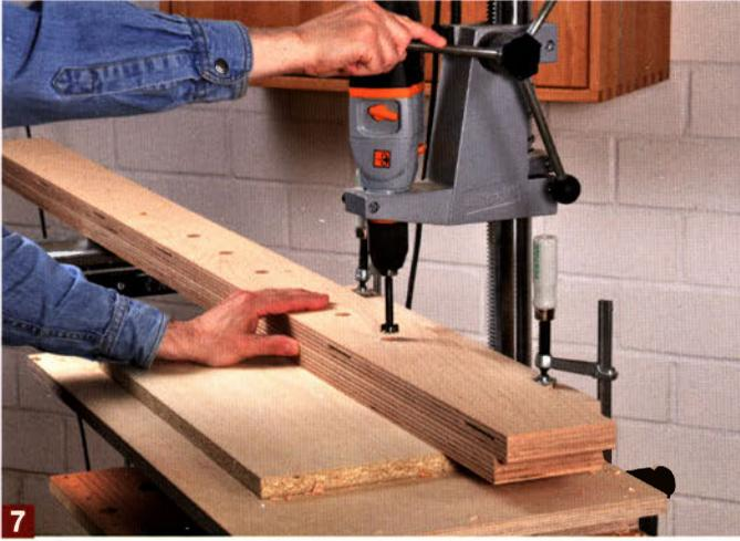
Während der Leim trocknet, können Sie eine lange Außenzarge mit der um 50 mm kürzeren Mittelzarge mit ein paar Spanplattenschrauben aufdoppeln und anschließend die 19 mm Löcher für die Rundbankhaken einbohren.
