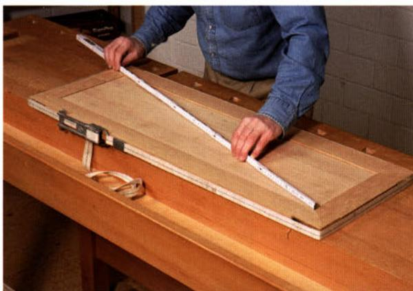
> Sofort nachdem der Spanngurt angezogen wurde, sollten Sie unbedingt mit einem Meterstab die Rechtwinkligkeit des Rahmens überprüfen, indem Sie beide Diagonalen nachmessen.
