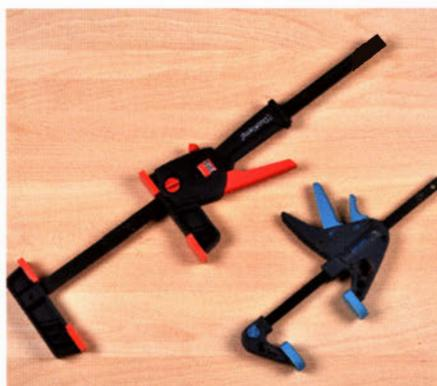
Einhandzwingen besitzen einen Spannkopf, der bequem mit einer Hand vor und zurück „gepumpt“ wird. Durch Umstecken des ...
