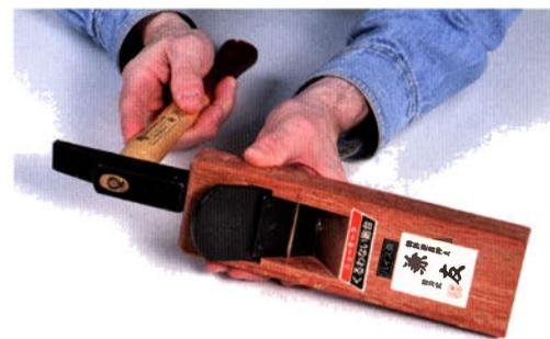
Mit einem oder mehreren beherzten Hammerschlägen auf die hintere Schmalseite des Hobels, können Sie die Schneide wieder zurück in den Hobelkörper treiben. Achten Sie auch darauf, dass die Schneide parallel zur Hobelsohle verläuft.
