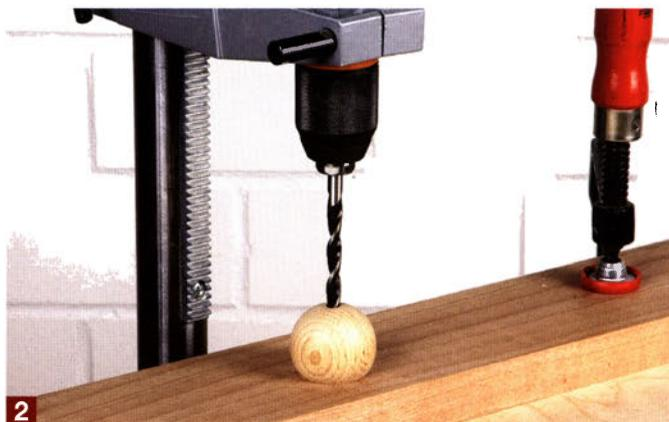
**2** ... und durch den gewünschten Bohrer ersetzt. Jetzt wird nur noch die Kugel auf das zuvor gebohrte Loch gesetzt, wobei sie nur auf dem Rand der Bohrung aufliegen darf.
