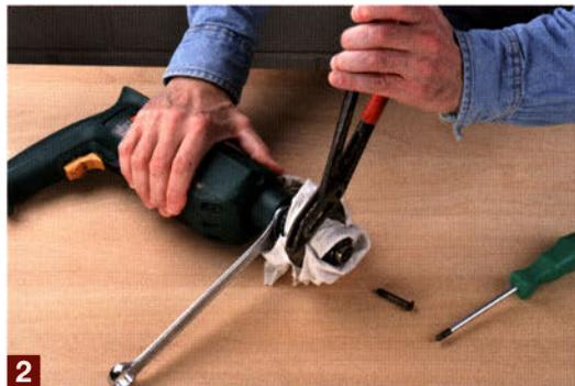
Das neue Bohrfutter zunächst nur von Hand aufdrehen. Die Sicherungsschraube mit Linksgewinde noch nicht eindrehen!
