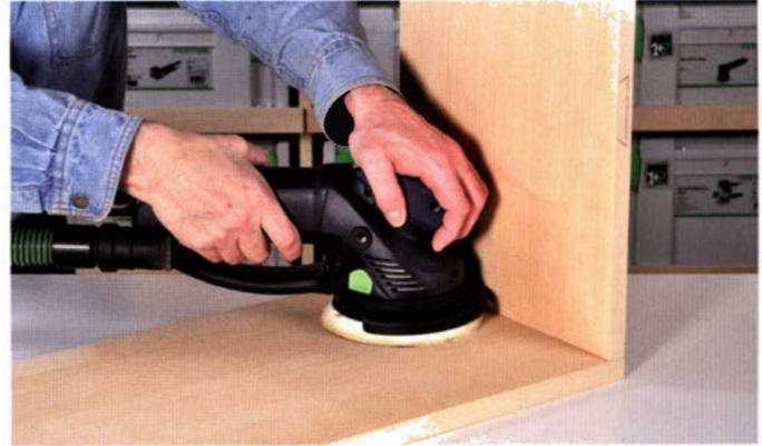
Ist der Kunststoffschutz montiert, bleibt immer genügend Abstand zwischen Schleifteller und angrenzende Flächen. Sie können völlig gefahrlos immer bis dicht an den Rand anderer Werkstücke heranschleifen.
