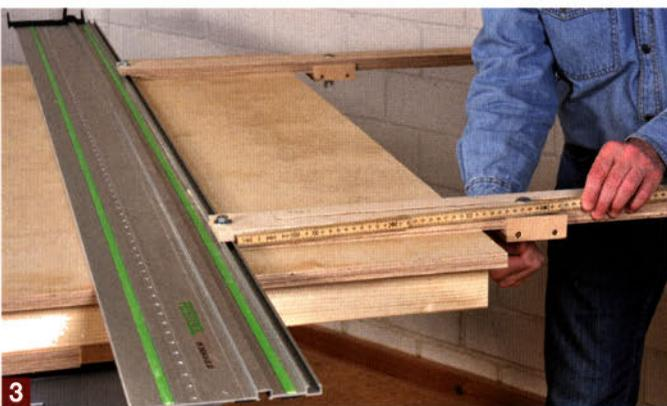
3 Anschließend stellen Sie mithilfe der verschiebbaren Anschlagreiter die gewünschte Brettbreite ein und legen sie dicht gegen die zuvor schnurgerade gesägte Plattenkante.
