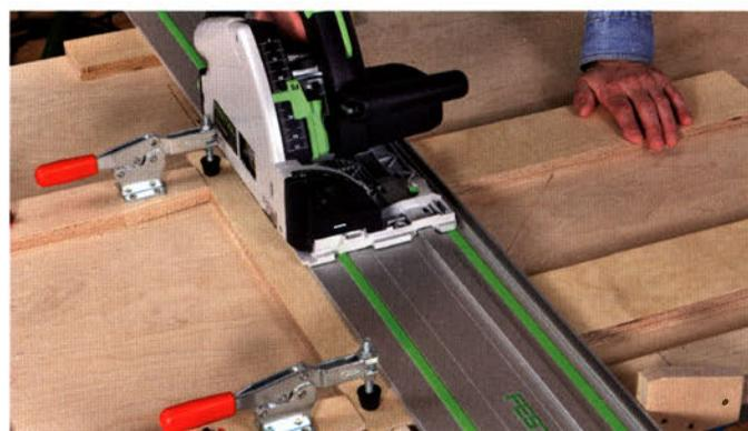
Auf diese Weise lassen sich problemlos bis zu 40 mm schmale Plattenstreifen absolut gleichmäßig und präzise zuschneiden.
