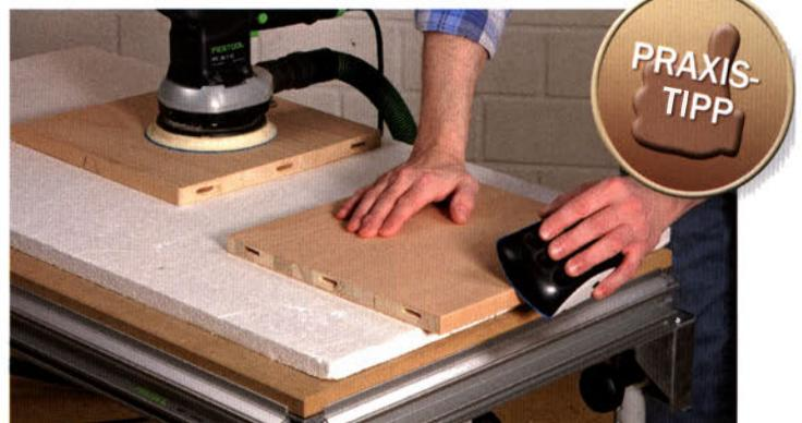
**Eine Styroporunterlage** schützt z. B. das dünne Furnier von Tischlerplatten vor Dellen und Kratzern durch eingedrückte Späne, die auf der harten Oberfläche des Werkzeugs liegen können.
