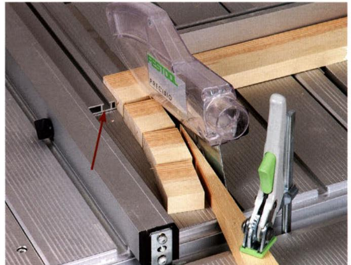
... müssen Sie das Anschlaglineal des Parallelanschlags in die flache Position bringen (Pfeil) und so weit zurückziehen, dass der Anfang des Sägeblatts etwa dem Anfang des Anschlaglineals entspricht (Pfeil Foto oben). Die Abschnitte müssen frei liegen und dürfen vom Anschlag nicht eingeklemmt werden!
