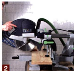
2 Säge einschalten und Sägeblatt ins Werkstück eintauchen
