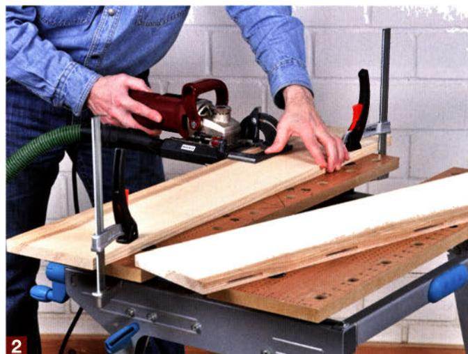
2 Klappen Sie den Schwenkschlag auf 90° in die flache Position, richten Sie die Mittenmarkierung der Maschine auf die Bleistiftstriche aus und fräsen Sie zwei Flachdübel in die Kanten der Bretter.
