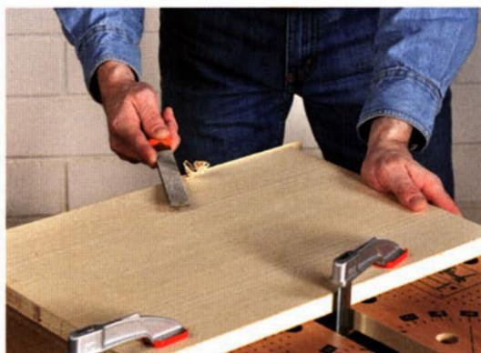
Bei Echtholzumleimern setzen Sie dafür aber besser eine handelsübliche Flachfeile ein. Selbst bei schwierigem Maserungsverlauf ist das Abfeilen des Überstands die schnellste, sicherste und sauberste Methode.
