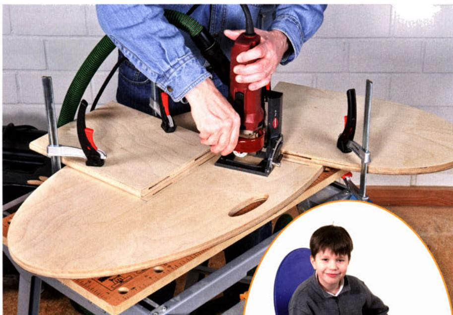
Selbst bei Werkstücken mit vielen geschwungenen Kanten lassen sich oft noch Flachdübel einsetzen, solange die beiden zu verbindenden Flächen gerade verlaufen. Dazu werden z. B. Sitz und Rückenlehne dieses Kinderschaukelstuhls einfach auf die Seitenteile festgespannt und als Anlagekante für die Maschine benutzt.
