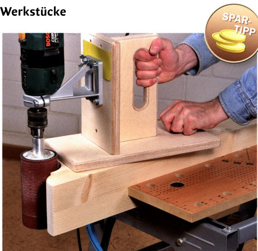
Ein mit der Stichsäge grob zugeschnittenes Kopfende eines 12 x 12 cm dicken Balkens können Sie mit diesem Kantenschleifgerät im Handumdrehen genau rechtwinklig nachschleifen. Lediglich bei scharfen Innenecken müssen Sie noch mit Holzfeile und Schleifpapier nacharbeiten.
