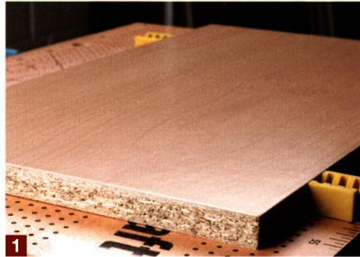
Die mit drei bis vier Lackschichten versehene Oberfläche sieht schon ganz gut aus. Lediglich ein paar Unebenheiten müssen glatt geschliffen werden.
