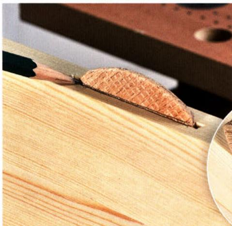
Stecken Sie den Flachdübel in den Schlitz und markieren Sie sich die Eintauchtiefe mit einem Bleistift. Danach den Flachdübel auch mit der anderen Rundung einstecken und wieder die Tiefe markieren, dabei muss die erste Markierung bereits im Schlitz liegen und darf nicht zu sehen sein.
