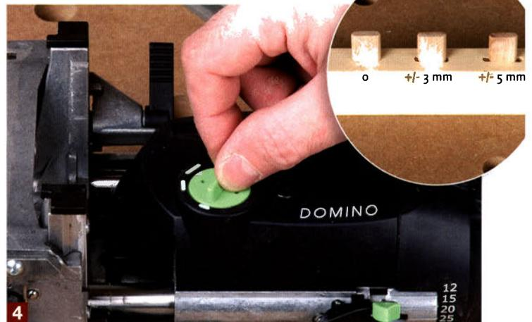
**4** Die Schlitzbreite lässt sich über den Drehschalter (nur bei laufender Maschine betätigen!) so einstellen, dass der Dominodübel genau und ohne Spiel in den Schlitz passt, oder um 6 bzw. 10 mm seitlich verschoben werden kann.
