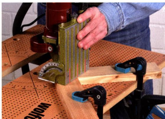
Beide Werkstücke genau zusammen legen und mit Zwingen gegen verrutschen sichern. Maschine auf 20er Frästiefe einstellen, dann hochkant und mittig auf die Verbindungsfuge platzieren und ein bis zwei Schlitze einfräsen.
