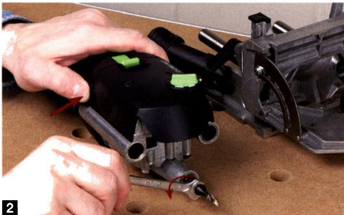
**2** ^ Drücken Sie die Spindelarretierung (Pfeil) und lösen durch Drehen des Maulschlüssels in Pfeilrichtung den Fräser. Drehen Sie den neuen Fräser zunächst von Hand auf das Gewinde und ziehen Sie ihn zum Schluss noch mal mit dem Maulschlüssel fest.
