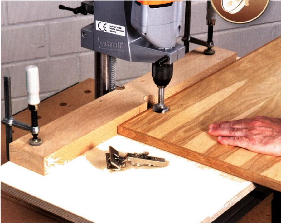
Präzise, tiefengenaue und exakt senkrecht verlaufende Löcher sind die Spezialität eines Bohrständlers. Eine stabile Unterlage aus Multiplex und eine Hartholzleiste als Anschlag können Sie leicht selbst nachrüsten.
