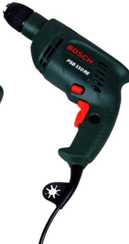
Eine Bohrmaschine oder ein Akkuschauber reichen zum Einbohren der Dübel völlig aus. Vorteile des Akkuschaubers: er ist in der Regel leichter und hat kein störendes Kabel. Achten Sie aber darauf, dass Sie im 2. Gang (schnellste Drehzahl) bohren und die Drehmomentregulierung ausschalten bzw. auf das Bohrsymbol stellen.
