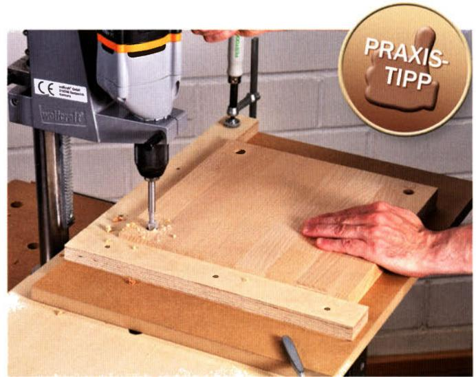
Wenn Sie z. B. ein schickes Regal mit Holzböden und Edelstahlstäben herstellen möchten und an den Ecken immer absolut gleiche Bohrungen benötigen, ist diese einfache Vorrichtung genau das Richtige. Zwei Leisten werden genau 90° zueinander auf eine Platte geschraubt, eine Bohrung wird angezeichnet und die Platte danach auf dem Bohrständler ausgerichtet und festgespannt.
