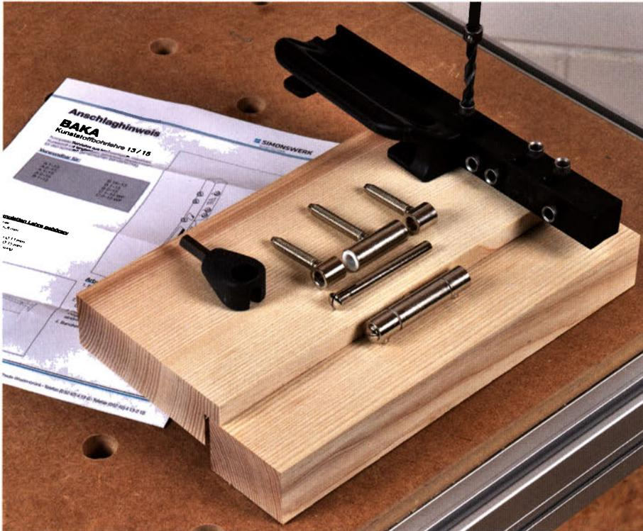
Für die dreiteiligen Türeinbohrbänder gibt es auch die passende Bohrlehre samt Anleitung. Trotzdem sollten Sie an Resthölzern zunächst einen Probeanschlag der Bänder durchführen.
