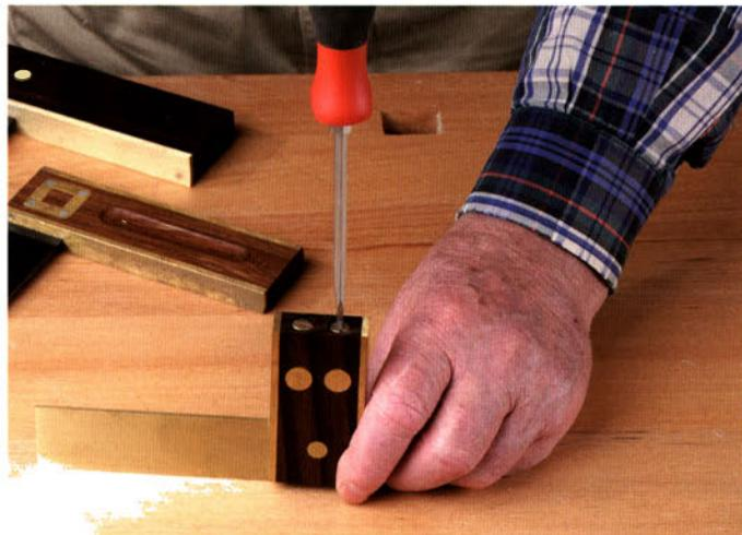
Die hochwertige Messingzunge dieses Winkels (Fa. Crown) kann über diese beiden Schrauben exakt im rechten Winkel zum Anschlag eingestellt werden. Damit lässt er sich möglicherweise auch bei einem Sturz von der Werkbank wieder genau nachjustieren.
