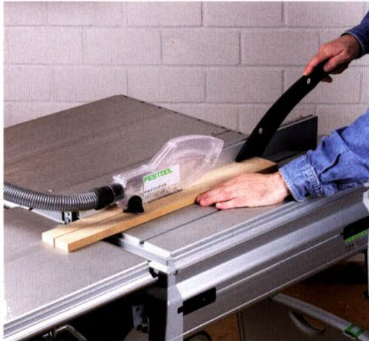
Sollen besonders schmale Leisten zugeschnitten werden, muss das Alulineal am Anschlag in eine flache Position gebracht werden, damit es nicht gegen die Spanhaube stößt. Wird das Sägeblatt zusätzlich noch geschwenkt, haben Sie so auch mehr Platz zum Führen des Werkstücks.
