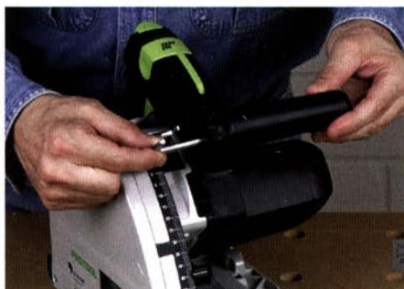
Das zum Wechsel nötige Werkzeug sollte sich immer direkt an der Maschine befinden (hier der Innensechskantschlüssel im Handgriff der Tauchsäge).
