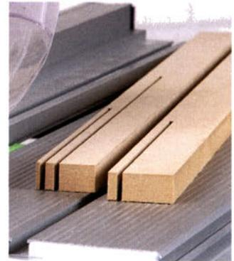
Beim Zuschchnitt von schmalen Leisten unter 30 mm Breite sollten Sie anstelle des Schiebestocks besser ein Führungsholz verwenden. Damit können sogar extrem schmale Leisten (Anleimer, Glashalteleisten etc.) präzise und gefahrlos zugeschnitten werden.
