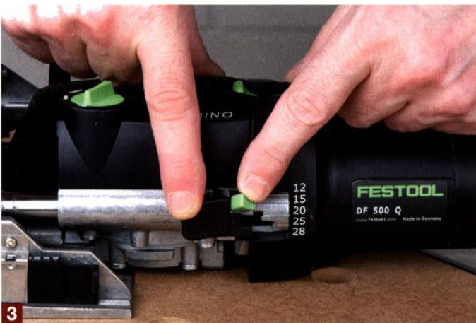
**3** Die Frästiefe wird an der Maschinenseite eingestellt. Dazu muss zunächst ein schwarzer Entriegelungsknopf gedrückt werden, bevor der grüne Schieber auf die gewünschte Tiefe eingestellt werden kann.
