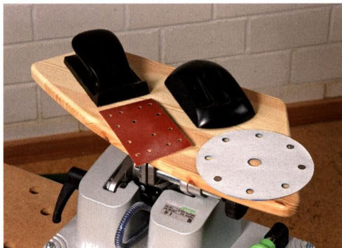
Ein ordentlicher Handschleifklotz ist ideal zum Schleifen der Holzkanten. Aber auch der letzte feinste Endschliff gelingt am besten mit der Hand. Auf diesen Modellen können die gewohnten Schleifmittel für die Maschinen benutzt werden.
