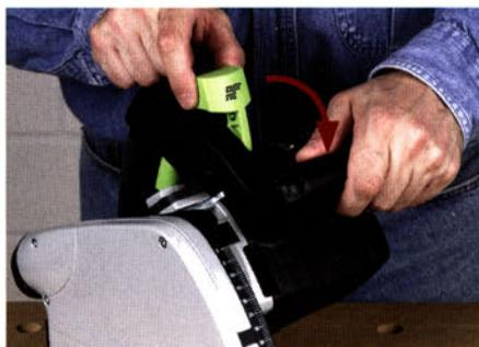
Optimal ist eine Arretierfunktion mittels Hebel die sowohl das Sägeblatt blockiert (Hebel dazu bis zum Anschlag nach vorne in Pfeilrichtung drehen), ...
