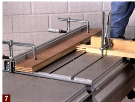
7 Zum Absetzen des Zapfens spannen Sie ein 80 mm breites Brett an den Längsanschlag. Dort liegt beim Sägen das Zapfende an und die Abschnitte können sich nicht zwischen Sägeblatt und Parallelanschlag verklemmen, sondern bleiben frei darunter liegen.
