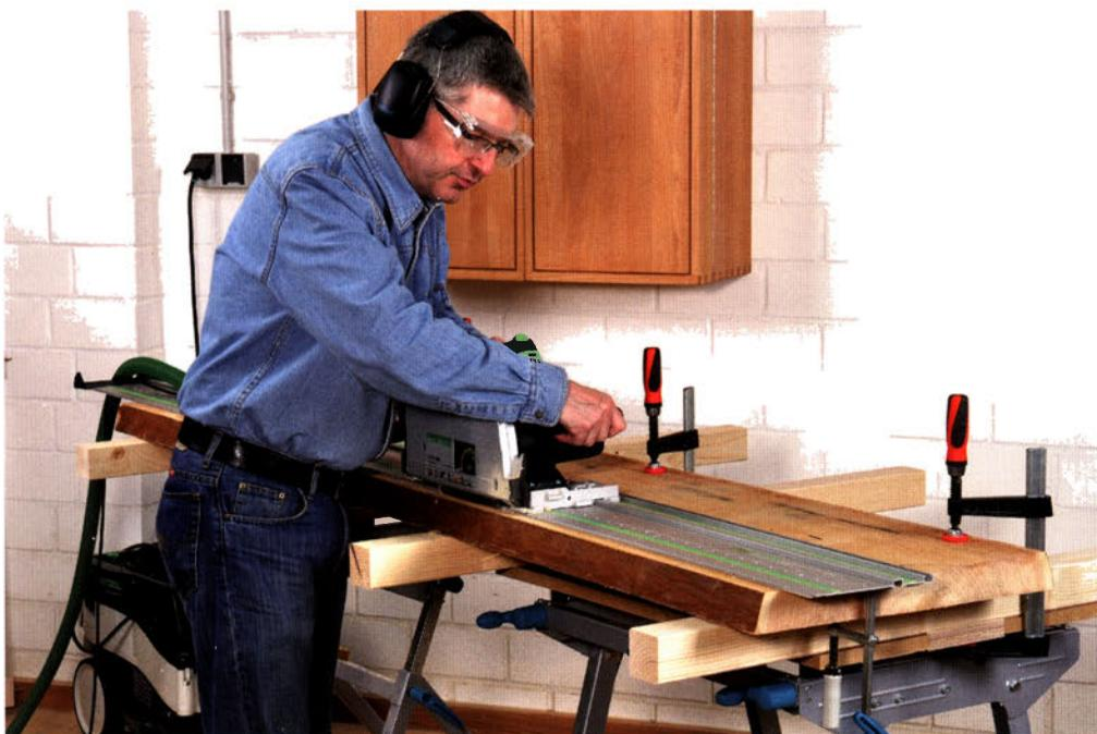
Entweder nutzen Sie als Unterlage ein paar stabile Arbeitsböcke oder wie hier 60 x 60 mm gehobelte Balken (ca. 115 cm lang), die Sie einfach in einen Spanntisch oder die Hobelbank einspannen.
