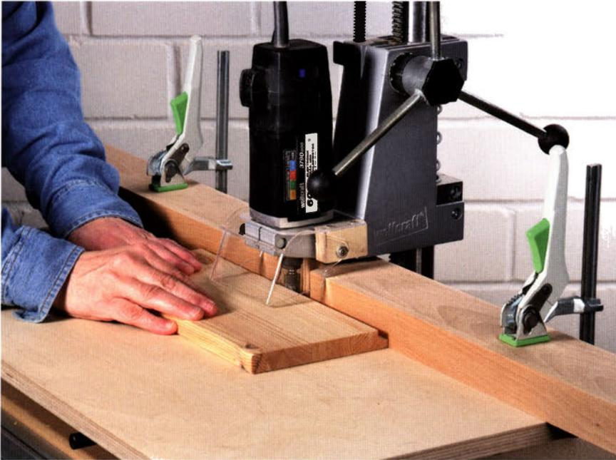
Mit einem Fräsmotor mit Eurohalsaufnahme wird ein handelsüblicher Bohrständer im Nu zur stationären Tischfräse mit unbeschränkter Sicht auf Fräser und Werkstück. Ganz wichtig: Im Gegensatz zum Frästisch müssen Sie bei dieser Anwendung das Werkstück immer von links nach rechts am Fräser vorbeischieben – niemals umgekehrt!
