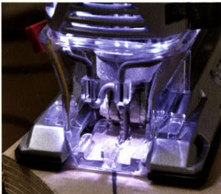
Spanflug- und Splitterschutz sind aus Plexiglas gefertigt, damit man den Schnittverlauf des Sägeblatts besser verfolgen kann. Bei neueren Modellen leuchtet eine kleine LED-Lampe zusätzlich den Ausriss perfekt aus. Wenn Sie den Spanflugschutz montiert haben, sollten Sie die Stichsäge aber unbedingt an ein Absauggerät anschließen, damit die Sägespäne nicht die Sicht behindern.
