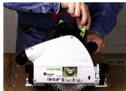
Zum Schluss den Hebel wieder nach hinten in Pfeilrichtung zurück drehen, dabei verschwindet das Sägeblatt wieder komplett im Gehäuse.
