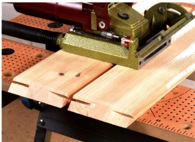
Die Mitte der Maschine dort ausrichten, wo beide Werkstücke zusammenstoßen und einen Schlitz fräsen. Anschließend die beiden anderen Werkstückkanten zusammenlegen und ebenfalls einen Schlitz fräsen.
