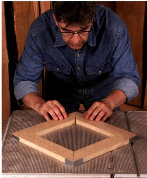
Ist ein Spalt in der Gehrung zu sehen, muss der Anschlag neu justiert werden. Befindet sich der Spalt im Inneren des Rahmens (s. unten), ist der Winkel des Anschlags zu „spitz“ eingestellt und muss ein wenig zurückgeschwenkt werden.
