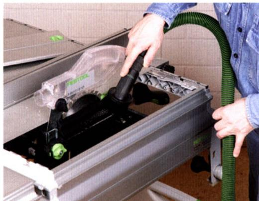
Damit die Maschine exakt und sauber zuschneidet, ist es zunächst wichtig, Staub- und Schmutzablagerungen regelmäßig von der Säge durch Absaugen zu entfernen. Benutzen Sie auf keinen Fall Druckluft zum Säubern, da auf diese Weise sehr schnell Staub in Motor, Elektronik oder Führungsstangen gelangt. Die Führungsstangen sollten danach jedesmal leicht eingefettet werden, damit die Zugfunktion auch leichtgängig und ruckfrei funktionieren kann.
