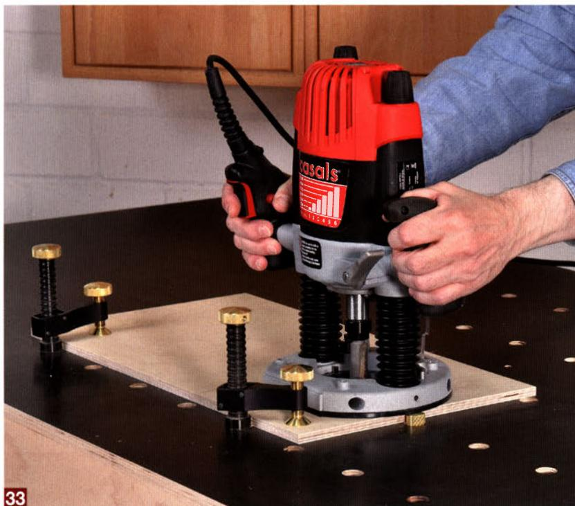
^ Da die Siebdruckplatte den Fräser sehr schnell stumpf werden lässt, sollten Sie damit nur die ersten 10 bis 15 mm Tiefe bohren, den Rest erledigen Sie dann am besten mit einem solchen 19 mm Forstnerbohrer.
