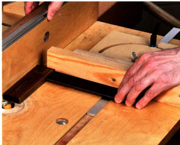
Fräsen Sie den Zapfen von beiden Seiten mit einem breiten Nutfräser an. Fräsen Sie in mehreren Durchgängen bis die Stirnkante am Anschlag anliegt.
