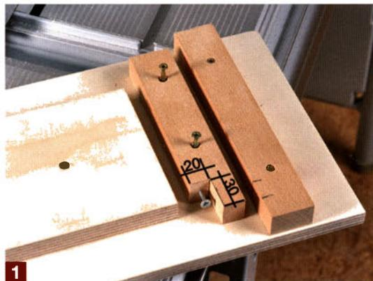
Beispielrechnung: Der Pfostenquerschnitt beträgt 38 mm und soll an allen Seiten um je 10 mm konisch zugeschnitten werden. Dazu wird zuerst die Leiste im Abstand von 18 mm auf die Platte geschraubt (38 mm abzgl. 2 x 10 mm) und anschließend die Schraube so verstellt, dass sich ein Abstand von 28 mm (38 mm abzgl. 1 x 10 mm) zwischen Schraube und Plattenkanten ergibt. Durch das wechselseitige Anlegen an diese beiden Anschlagpunkte, ergibt sich dann ein um 10 mm konisch zulaufender Pfosten.
