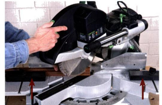
Rechte Gehrung sägen: Die Säge muss dazu in die andere Richtung geschwenkt und erneut mit der Schmiege eingestellt werden. Diesmal müssen Sie die Säge mit der linken Hand bedienen und die Leiste mit der rechten Hand fest gegen den Anschlag drücken.
