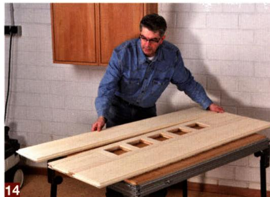
Nachdem Sie an die Füllungen passend zur Nut rundum eine Feder angefräst (gefälzt) haben, schieben Sie zuerst die beiden kurzen ...
