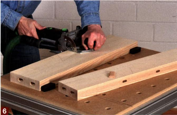
Zum Einfräsen der Sprossen in die dickeren Querrahmenfrieze müssen Sie den Klappanschlag der Dominofräse wieder neu auf die halbe Rahmenstärke einstellen (20 mm!).
