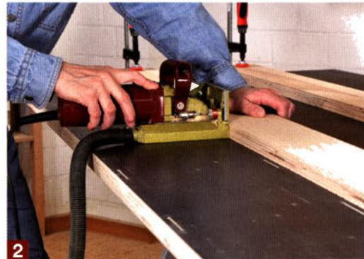
Damit die 30er Siebdruckplatte nicht durchhängt werden zwei lange Querzargen mit Flachdübeln verbunden. Dazu die Zargen auf der rauhen Siebdruckfläche festspannen und die Maschine zuerst hochkant anlegen (1) und den Schlitz in die Platte und erst danach den passenden Gegenschlitz in die Zarge fräsen (2).
