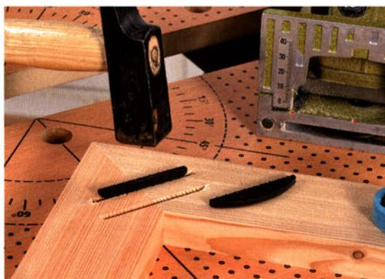
Beide Stirnflächen (Gehrungsflächen) mit Leim versehen und die beiden Lamellen ungefähr mittig in die Schlitze einschlagen. Wenn Sie die Frästiefe etwas erhöhen, können Sie die Lamellen auch tiefer ins Holz einschlagen und mit farblich passendem Wachs-kitt abdecken.
