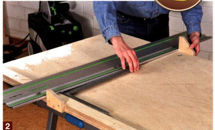
2 Zur genauen Positionierung der Führungsschiene befindet sich an der Vorderkante ein fest verschraubtes Brettchen und an der Rückkante ein verschiebbares Winkelbrett. So lässt sich ein präziser 90°-Winkel einstellen.
