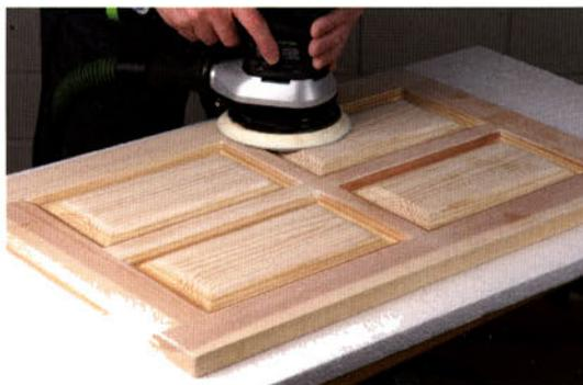
Die glatten Türflächen können mit dem Exzentrerschleifer problemlos bearbeitet werden. Die Profile der Rahmen und Füllungen müssen jedoch von Hand geschliffen werden.
