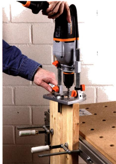
Bei einem älteren Modell (Bild links) lassen sich die Führungsstangen aus der Grundplatte heraus schieben. Die Werkstückkante wird dann zwischen den Stangen eingeklemmt und im Nu können exakt senkrechte Löcher genau mittig in schmale Holzseiten gebohrt werden.
