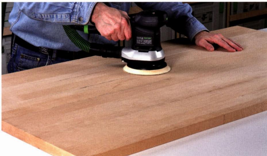
Der Exzentrerschleifer mit 150er Schleifteller und 3 mm Schleifhub ist der ideale Einstiegs- und Allroundschleifer. Er ist hervorragend einsetzbar für Vor-, Zwischen- oder Endschliff von Holz, Plattenwerkstoffen sowie lackierten oder geölten Oberflächen.
