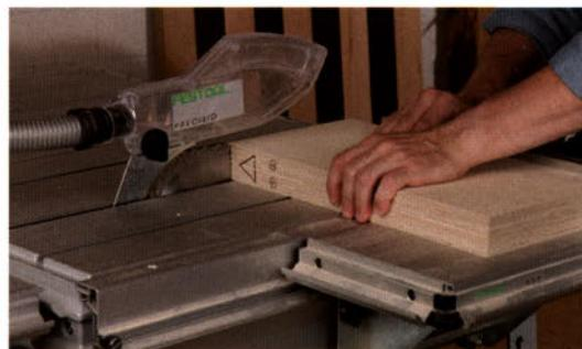
Die Rechtwinkligkeit des Schiebeschlittens testen Sie, indem Sie zwei gleich große flach aufeinandergelegte Holzplatten abgesägt.
