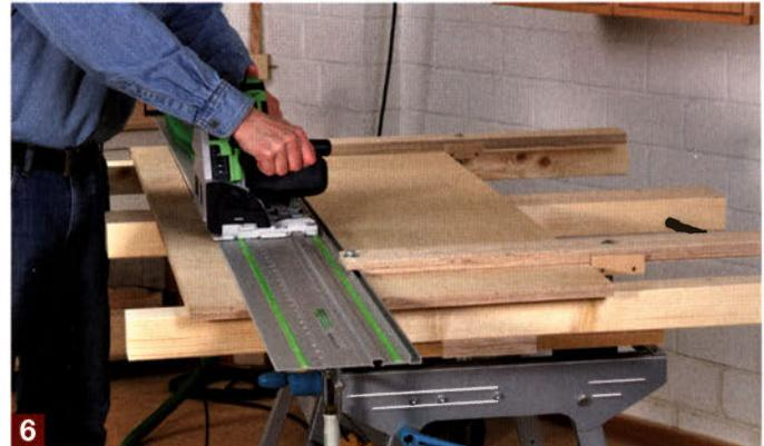
... kann gleich wieder als Anlegekante für den nächsten Schnitt genutzt werden. Auf diese Weise können Sie absolut parallele Breitenzuschnitte von etwa 200 bis 780 mm herstellen. Und wenn Sie die Anschläge unterschiedlich einstellen, sind auch schräge Bauteile kein Problem.
