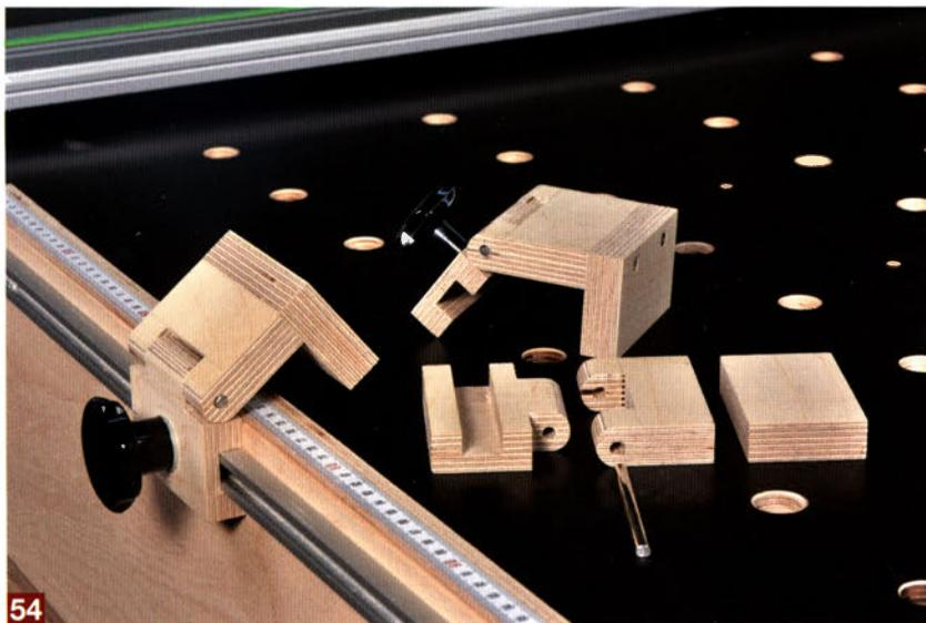
Klappbare Anschlagreiter lassen sich mit etwas Geschick auch leicht selbst herstellen. Auf einer selbstklebenden Skala können Sie dann später bequem die Werkstücklänge ablesen.
