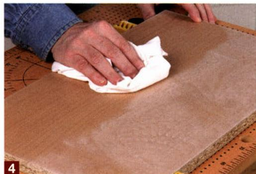
Reiben Sie zwischen jedem Schleifvorgang den restlichen Schleifstaub sorgfältig mit einem Baumwollappen von der Oberfläche.
