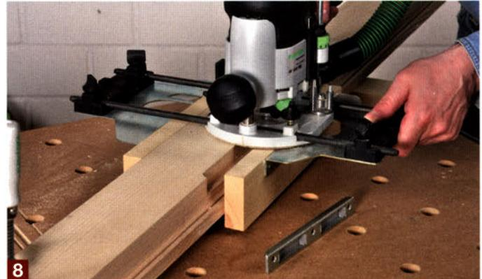
Das Winkelschließblech ist innen mit einem Kunststoffgehäuse aufgefüttert, daher müssen Sie nur mit der Oberfräse und einem 20-mm-Nutfräser einen eingesetzten Falz ausfräsen.
