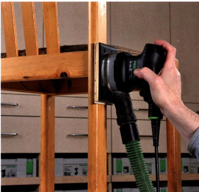
^ Ein leichter und handlicher Schwingschleifer ist besonders dann zu empfehlen, wenn häufig an schmalen Teilen, senkrechten Flächen oder über Kopf geschliffen werden muss.
