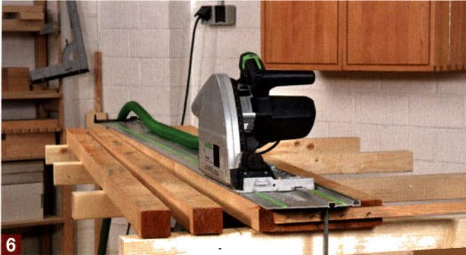
6 Jetzt können Sie sicher und bequem auch den gesamten Rest der Bohle im gewünschten Maß auftrennen. Wichtig: Setzen Sie hierfür immer ein Sägeblatt mit wenigen Zähnen (z. B. Z 16) und großen Spanlücken ein.
