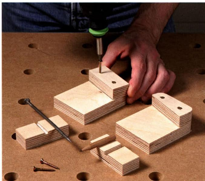
Zuerst werden die beiden oberen Klötzchen entsprechend der Schräge des Keils mit zwei Spanplattenschrauben befestigt. Danach auf dem Tellerschleifer die Ecken abrunden.
