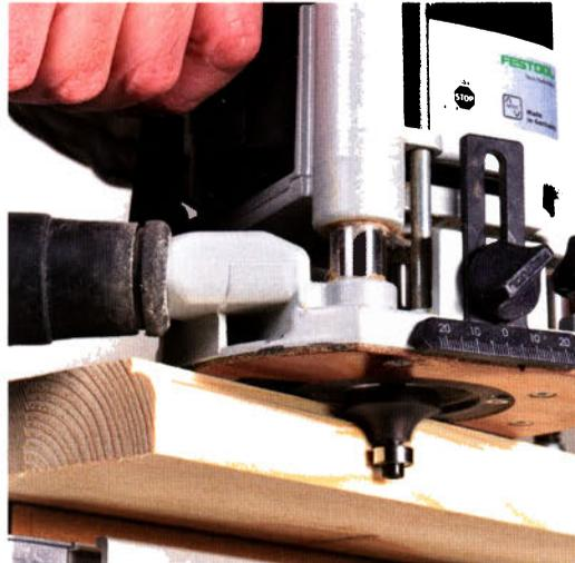
**Parallelanschlag:** Bei Nut- und Profilfräsern ohne Kugellager wird die Fräse mittels Parallelanschlag oder einer Führungsschiene „auf Kurs“ gehalten.
