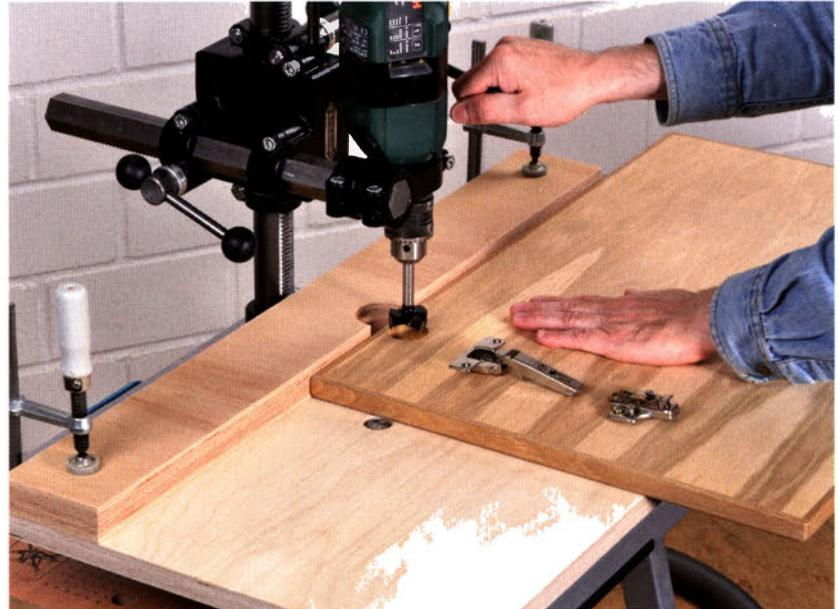
Mit einem Bohrständer sind präzise senkrechte Löcher kein Problem. Mit einem Maschinenschraubstock können dann selbst komplizierteste Werkstücke während des Bohrvorgangs sicher festgespannt werden (Bild li.). Ein zusätzlicher Tiefenstopp im Bohrständer sorgt für präzise Bohrtiefen, beispielsweise beim Bohren von Topfscharnierlöchern (Bild oben). Mehr zur Arbeit mit einem Bohrständer finde Sie ab Seite 110.
