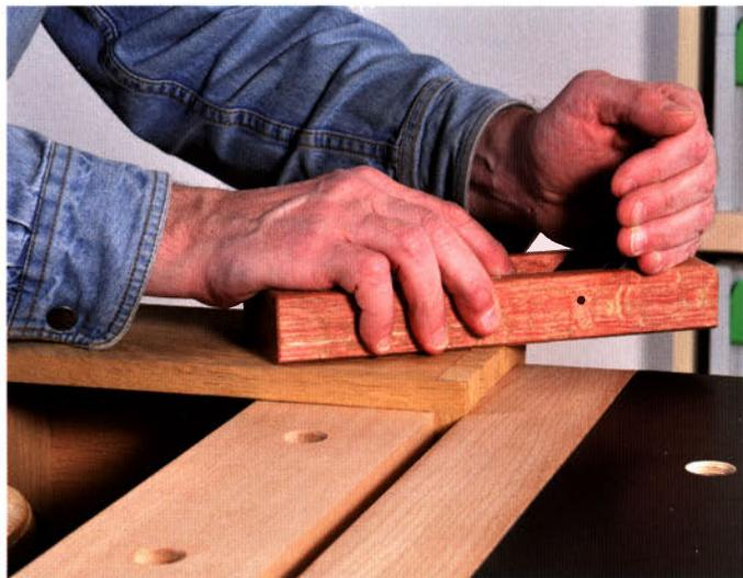
Den Überstand einer Zinkenverbindung bei einem Schubkasten können Sie mit einem Hobel präziser abnehmen als mit einer Schleifmaschine, bei der immer die Gefahr besteht die Seitenwände schräg zu schleifen.
