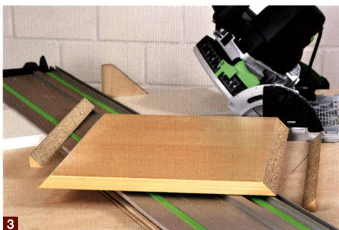
Achten Sie beim Sägen auf einen gleichmäßigen Vorschub der Tauchsäge und sorgen Sie dafür, dass die Säge mit der Führungsnut immer auf der Schiene bleibt. Durch die Schrägstellung besteht eine erhöhte Kippgefahr, der man durch Druck mit der linken Hand entgegen wirken muss.
