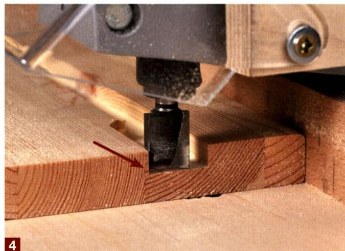
**4** ... achten, dass Sie den Anschlag entsprechend nach hinten verschieben, damit die Nut im vorderen Bereich verbreitert wird (Pfeil). Andernfalls fräsen Sie im Gleichlauf mit erheblicher Rückschlagsgefahr!
