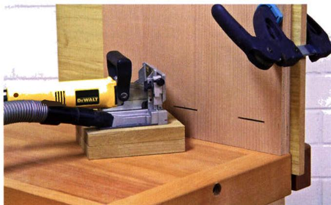
Damit der Schlitz bei dünneren Brettern (> 18 mm) ungefähr in der Kantenmitte liegt, wird einmal unter die Holzkannte ein Sperrholzbrettchen gelegt und beim Fräsen der Gegenslitze ein Sperrholz der gleichen Stärke unter das Brett z. B.: 12 mm Holzstärke mit 4 mm Sperrholz unterlegen.
