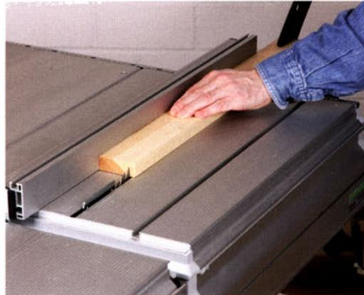
Mit der Tischkreissäge kann man selbst schwierige Holzarten extrem sauber und nahezu ausrissfrei nuten. Da das Sägeblatt aber nur eine Dicke von knapp 3 mm hat, müssen Sie für breite Nuten mehrere Schnitte nebeneinander machen, bis die gewünschte Nutbreite erreicht ist. Zum Nuten setzen Sie am besten ein Flachzahn-Sägeblatt ein.
