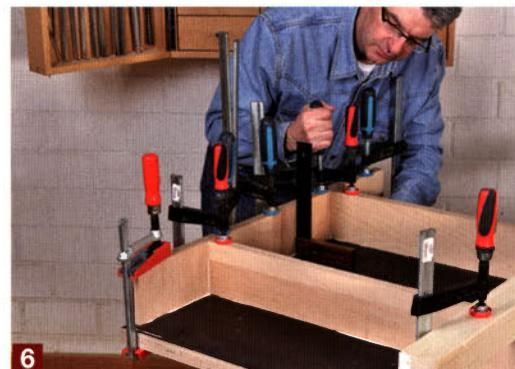
Wenn Sie alle Flachdübel gefräst haben, verleimen Sie zuerst nur die beiden mittleren Zargen auf die Siebdruckfläche. Achten Sie immer auf ...
