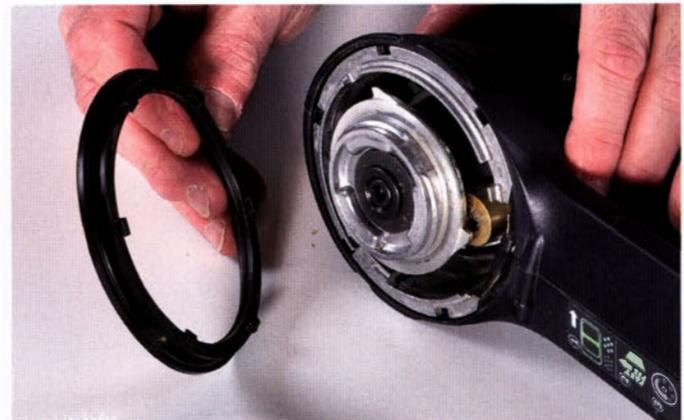
Auch ein Getriebeexzentrerschleifer verfügt über eine Tellerbremse in Form einer Gummimanschette, die bei Abnutzung als Ersatzteil problemlos nachbestellt und auch selbst gewechselt werden kann.
