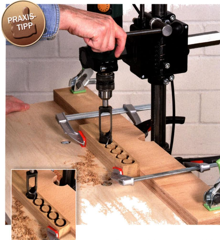
Auf den folgenden Bildern sehen Sie, wie Sie mit einem Scheibenschneider passende Querholzdübel herstellen, um damit die Schraubenköpfe einer Sitzbankfläche zu verdecken. Dazu müssen Sie zuerst mit einem Forstnerbohrer, der genau zum Innendurchmesser des Scheibenschneiders passt, ein ca. 7-10 mm tiefes Sackloch in die Sitzfläche bohren. Darin sitzt später der Schraubenkopf. Das Sackloch wird zum Schluss mit einem zur Holzfarbe und -maserung der Bankfläche passenden Querholzdübel verschlossen.
