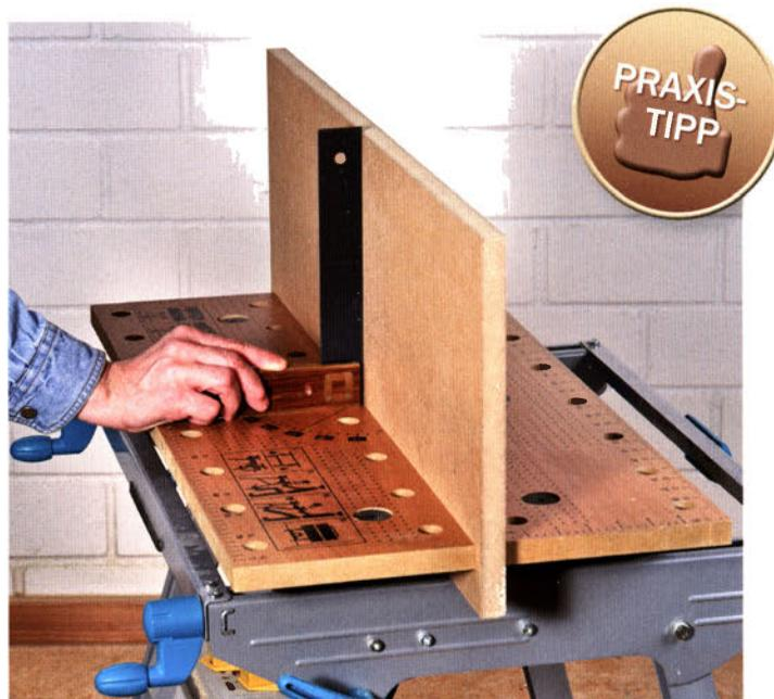
Als Stützwinkel spannen Sie einfach eine Platte hochkant in einen Spanntisch oder in die Vorderzange der Werkbank ein und überprüfen anschließend den rechten Winkel von Platte zur Tischfläche. Auch die Anschlagbacken einer Tischfräse oder eines Frästisches können hervorragend als Stützwinkel dienen. Auf diese Weise ist ein Regal (links) in gut 5 Minuten komplett mit Flachdübeln verbunden.
