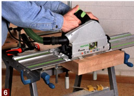
... denn in den nächsten beiden Schritten können Sie die Zapfenstärke noch genau anpassen. Dazu spannen Sie zuerst alle vier FüÙe zusammen und sägen mithilfe der Führungsschiene die Zapfenbrüstungen an.
