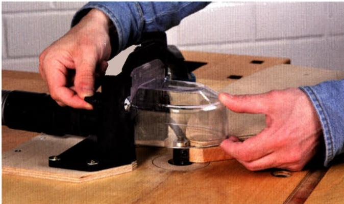
Die Plexiglashaube kann in der Höhe genau auf die Werkstückdicke plus Schablone eingestellt werden. Das erhöht nicht nur die Absaugleistung, sondern schützt auch die Finger.
