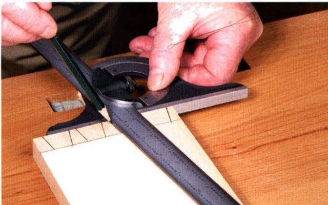
5. Mit dem Winkelmesskopf kann jeder Winkel von  $0^\circ$  –  $180^\circ$  präzise über die integrierte Skala abgelesen und eingestellt werden.
