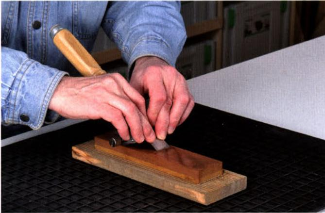
Zuerst wird immer die Fasse geschärft. Damit der Schärffstein gleichmäßig abnutzt und keine Dellen bekommt, sollte der Stechbeitel möglichst immer über die gesamte Fläche vor und zurück geschoben werden.
