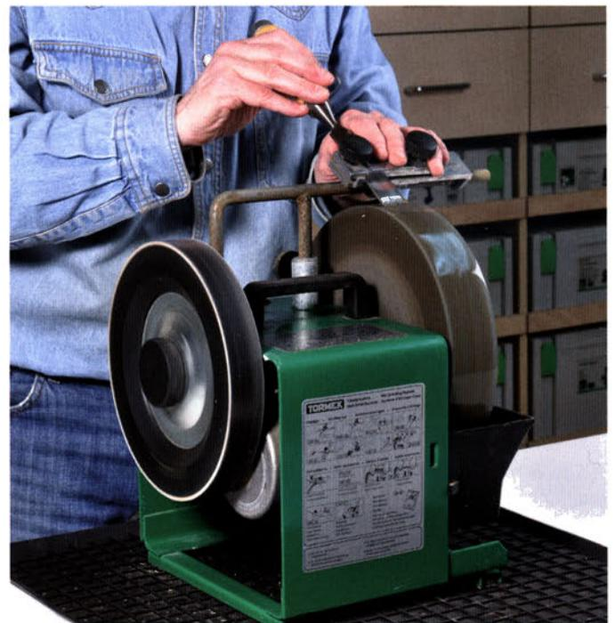
Die Schärffsteinscheibe saugt eine Menge Wasser, deshalb sollten Sie ab und zu auch etwas Wasser nachkippen. Lassen Sie den Stein auch nie längere Zeit im Wasserbad stehen, ohne dass er sich dreht. Auf der gegenüber liegenden Seite befindet sich eine Lederscheibe zum Abziehen und Polieren der Schneide.
