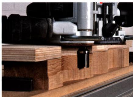
Danach schrauben Sie die Schablone auf das Holz und fräsen zuerst mit dem Bündigfräser (bei dem das Kugellager am Schaft läuft) die halbe Holzstärke ab. Dabei tastet das Kugellager genau den Verlauf der Schablone ab.
