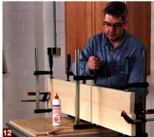
Die Füllungen werden aus zwei breiten Streifen verleimt. Dazu die Kanten, die zusammengeleimt werden, sauber abrichten (gerade hobeln), gleichmäßig mit Leim bestreichen und mit Zwingen fixieren. Nach dem Trocknen die gesamte Füllung auf genaue Dicke hobeln.
