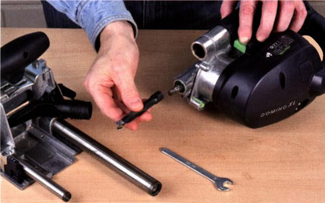
Der Fräserwechsel ist genauso einfach wie bei der kleinen Dominofräse. Fräser einfach von Hand auf das Gewinde der Spindel drehen und mit dem mitgelieferten Maulschlüssel festziehen – fertig.
