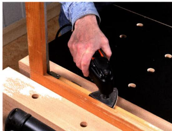
Neben den vielen Sägeblättern und Schneidwerkzeugen bieten alle Hersteller auch unterschiedliche Schleifplatten an, die im Nu aus der oszillierenden Säge ein vielseitiges Schleifgerät machen.
