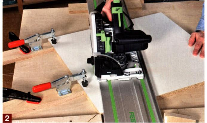
Mit zusätzlichen Anschlägen und Schnellspannern können Sie selbst komplizierte Bauteile beliebig oft maßgenau zuschneiden.
