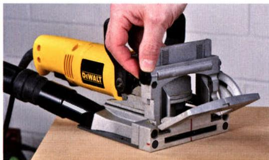
Es gibt auch Maschinen bei denen lässt sich der Schwenkansschlag zusätzlich noch über ein Zahnradgestänge millimetergenau in der Höhe verstellen.
