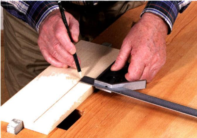
3. Durch den verschiebbaren Anschlag lässt sich der Kombinationswinkel auch hervorragend als Streichmaß einsetzen.
