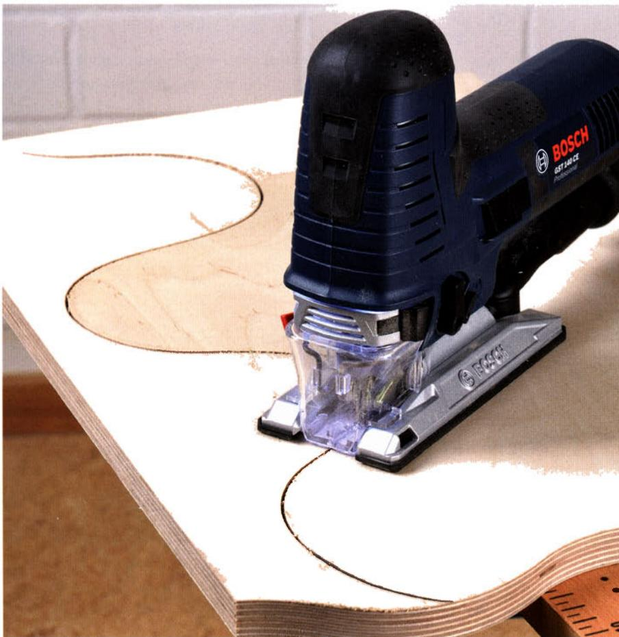
Die Stichsäge ist ein „Kurvenkünstler“, hier spielt sie ihre ganzen Stärken aus. Mit dem richtigen Sägeblatt bestückt, ist sie fast so wendig wie eine Laubsäge. Bei hochwertigen Modellen sorgen ausgeklügelte Sägeblattführungen dafür, dass das Sägeblatt auch bei dickerem Material nicht „verläuft“. Diese Sägeblattführung in Kombination mit einem hochwertigen Sägeblatt ergibt Schnittkanten, die fast keine Nachbearbeitung mit Feile und Schleifklotz erfordern.
