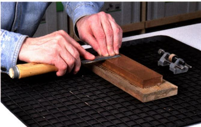
Anschließend wird die Schleifführung entfernt und die Rückseite (Spiegel) des Stechbeitels flach über den Schärffstein geschoben.
