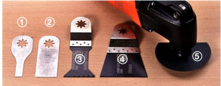
Die geraden Sägeblätter (1 + 2) sind ideal für filigrane Ausschnitte und lassen sich sehr genau an einer Bleistiftlinie ansetzen. Wenn etwas bündig zur Werkstückfläche abgesägt werden muss, kommen die gekröpften Sägeblätter (3 + 4) zum Einsatz. Für lange gerade Schnitte eignet sich ein kreisförmiges Sägeblatt (5) am besten.
