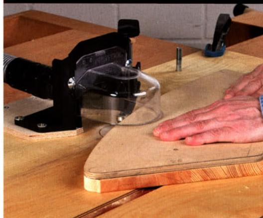
Der Bogenfräsanschlag wird anstelle des Längsanschlags eingesetzt, um geschweifte bzw. geschwungene Werkstücke zu bearbeiten. Dazu ist auch immer der Einsatz eines Fräasers mit Kugellager zwingend erforderlich. Das Kugellager fungiert dabei als Führungskante für Werkstück oder Schablone.
