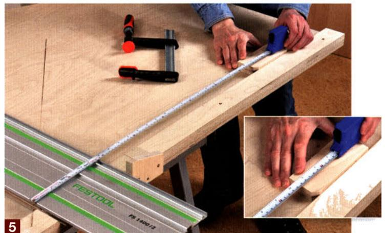
5 Stellen Sie dann die gewünschte Werkstücklänge mithilfe eines Anschlagbrettchens ein. Fixieren Sie es zum Schluss mit einer Zwinne.
