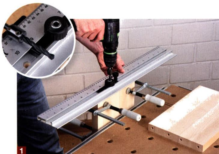
1 Die senkrechten 8er Dübellöcher in den Seitenteilen bohren Sie am besten mit der Dübelleiste. Benutzen Sie dazu unbedingt einen Metallbohrer, da er sich besser von der Bohrlehre führen lässt, als ein Holzbohrer mit Zentrierspitze.
