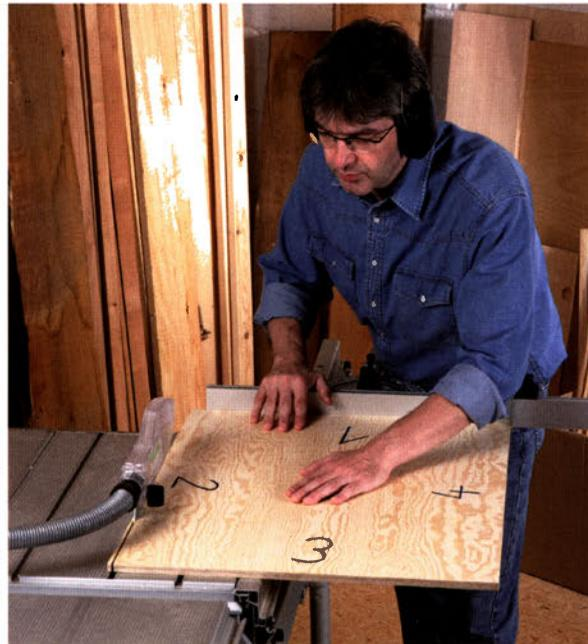
Zunächst alle Kanten gegen den Uhrzeigersinn von 1 bis 4 kennzeichnen. Die Kante mit der Nummer 1 gegen den Anschlag legen und von der Kante 2 einen ca. 5 mm breiten Streifen absägen. Jetzt die Kante 2 gegen den Anschlag legen und von Kante 3 einen Streifen absägen.
