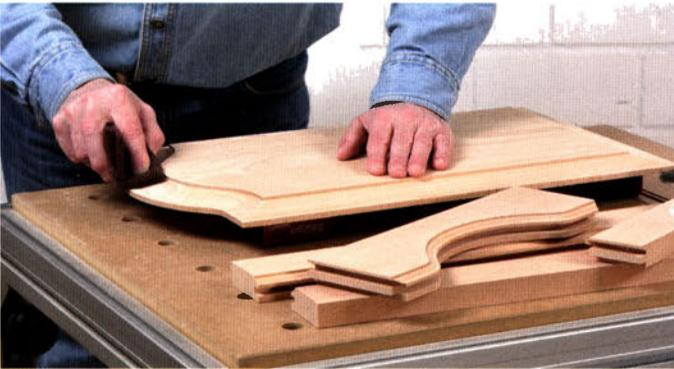
**Teile vor dem Zusammenbau schleifen** wie z. B. Profile von Füllungen und Rahmen, die man nach dem Verleimen nur mühsam erreicht. Aber auch die Flächen sollten vorher geschliffen werden. Später reicht ein leichter Schliff von Hand aus.
