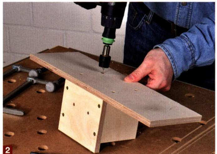
Anschließend legen Sie die Grundplatte (1) auf, lassen sie seitlich gleichmäßig überstehen und richten sie bündig zur Frontplatte aus. Diesen Grundaufbau dann zuerst zweimal herstellen!
