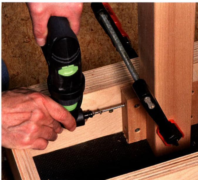
Wenn es ganz eng wird, ist ein Winkelvorsatz eine große Hilfe. Modelle, die nur über eine Sechskant-Bitaufnahme verfügen, sind dabei deutlich kürzer als Winkelbohrköpfe mit festem Bohrfutter. Und da es neben den Schrauberbits auch zahlreiche Bohrer mit Bitaufnahme gibt, können Sie damit auch hervorragend in der kleinsten Ecke oder Nische ein Loch bohren.
