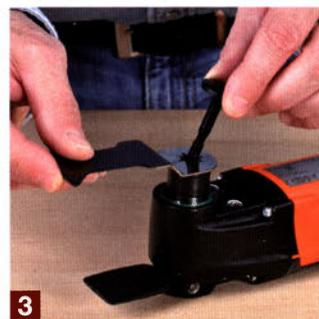
3 Werkzeug auflegen und Spannschraube einstecken
