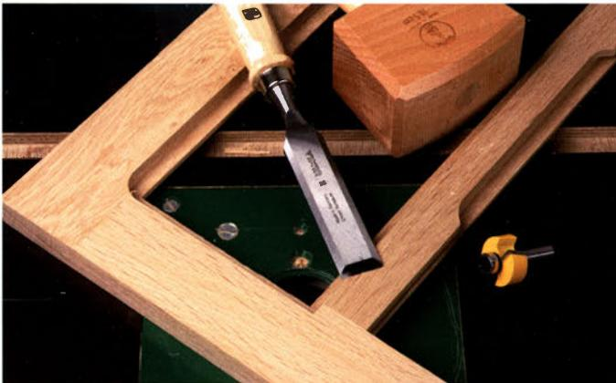
^ Egal wie Sie es anstellen, ein Fräser hinterlässt in den Ecken immer eine Rundung. Um beispielsweise in den Falz eine Glasscheibe einsetzen zu können, muss die Rundung anschließend noch mit einem scharfen, breiten Stechbeitel von Hand eckig nachgestemmt werden. Sie sehen – auch bei der Arbeit mit Elektrowerkzeugen benötigen Sie vernünftiges Handwerkzeug.
