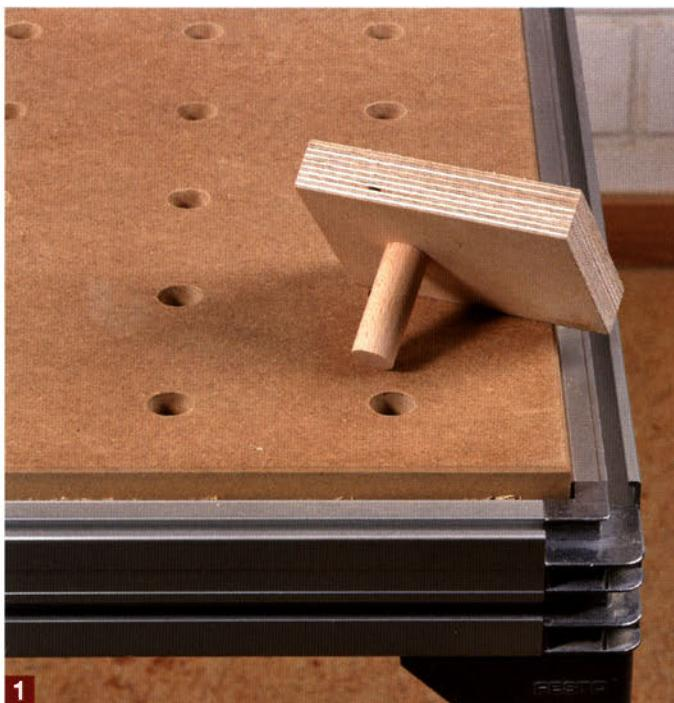
1 Ein 40 – 50 mm langer Rundstab (hier  $\varnothing$  20 mm) unter dem Multiplexbrett macht es möglich die Lampe an jeder Lochposition des Werkstisches einzustecken.
