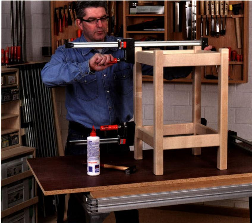
Um einen Hocker oder Stuhl so zu verleimen, dass er später auch nicht wackelt, benötigen Sie vor allem eine ebene und saubere Arbeitsfläche. Auf der Kunststoffbeschichtung lassen sich selbst ausgehärtete Leimreste problemlos mit einem Stechbeitel entfernen.
