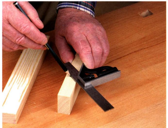
2. Mit der 45°-Anschlagseite sind auch Gehrungen schnell und präzise markiert.
