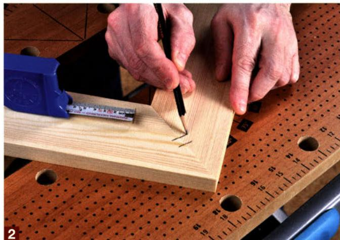
Zum Einfräsen des S6 zeichnen Sie sich zwei Striche mit 10 mm Abstand auf die Gehrungsfuge. Stellen Sie die Maschine auf die maximale Frästiefe ein, richten Sie die Mittenmarkierung auf den ...
