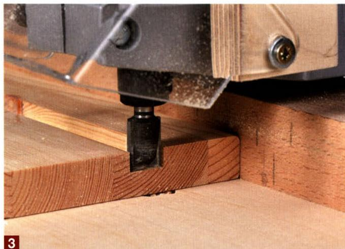
**3** Auch beim Nuten wird das Werkstück wieder von links nach rechts am Anschlag vorbeigeschoben. Soll die Nut breiter als der Fräser ausfallen, müssen Sie unbedingt darauf ...
