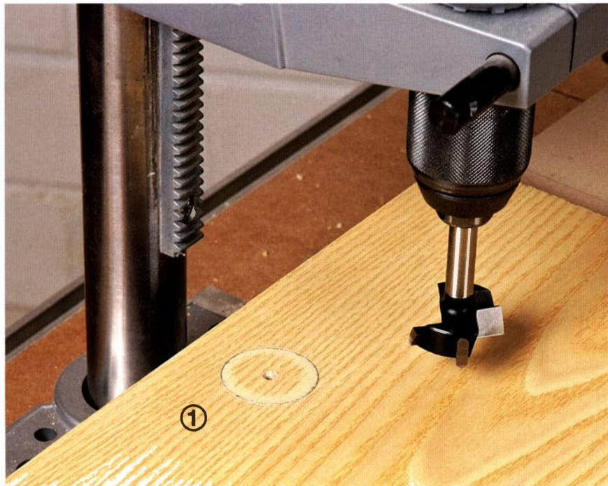
Ist die Tischfläche montiert, sollten Sie im nächsten Schritt die Bohrmaschine in die Eurohalsaufnahme einsetzen und überprüfen, ob die Bohrachse genau rechtwinklig zur Tischfläche verläuft. Denn nur dann sind auch exakt senkrecht verlaufende Bohrungen garantiert und das ist die mit Abstand wichtigste Funktion eines Bohrständers!
