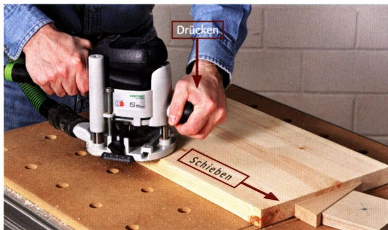
Schalten Sie die Fräse ein, drücken Sie mit der linken Hand die Maschine fest auf das Werkstück und schieben Sie sie vorsichtig gegen die Holzkante Ihres Werkstücks, bis sie merken, dass das Kugellager an der Kante anliegt. Die laufende Maschine bewegen Sie nun von links nach rechts, bis zum Ende der Holzkante. Die Grafik auf der nächsten Seite zeigt Ihnen, in welche Richtungen die Oberfräse geführt werden muss.
