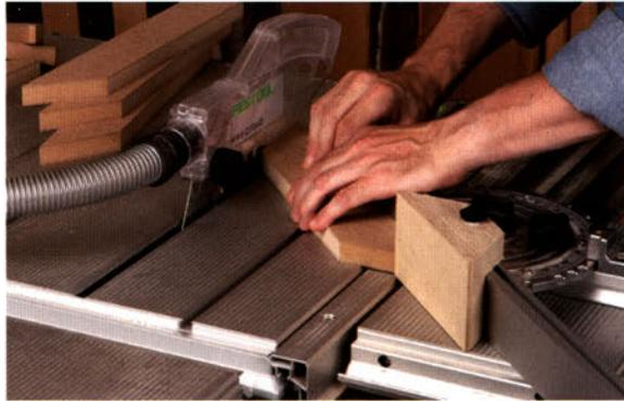
Nehmen Sie vier gleich lange Rahmenteile aus MDF und sägen Sie an beide Enden eine 45°-Gehrung an.
