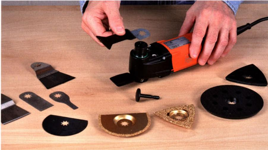
Zum Sägen stehen kreisförmige, kreissegmentförmige, spachtelförmige und einfache gerade Sägeblätter in HSS, Bi-Metall und sogar Hartmetall zur Auswahl. Mit den runden und dreieckigen Schleifplatten wird aus dem Multiwerkzeug im Nu eine leistungsfähige Schleifmaschine.
