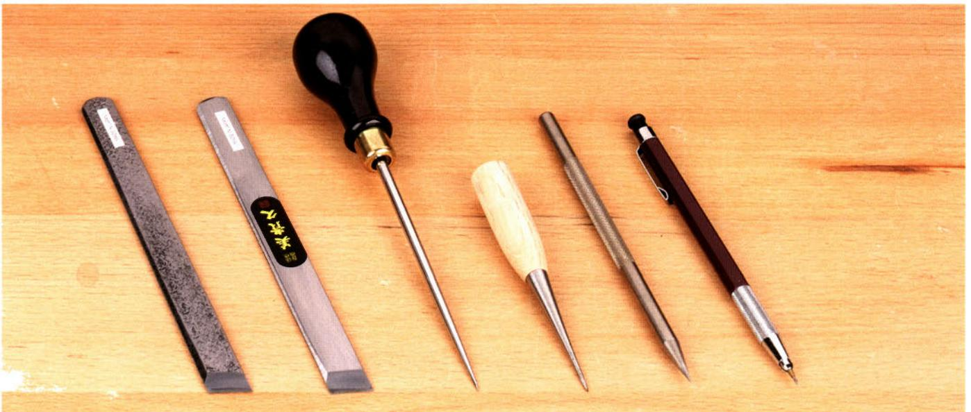
Neben dem Bleistift, können scharfe Anreißmesser, Spitzbohrer oder Stechhahl, sowie Reißnadeln zum Anreißen eingesetzt werden. Alle haben aber eines gemein: Sie zerstören die Werkstück-Oberfläche. Dafür ist die Ritzfuge aber auch auf Oberflächen sichtbar, auf denen ein Bleistift keine Linien hinterläßt.
