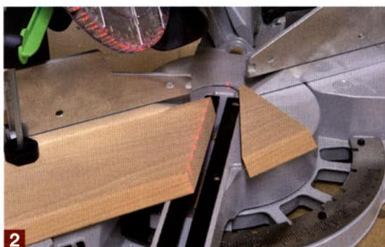
Wie präzise ein Doppellinien-Laser den Schnittverlauf markiert, lässt sich auf diesem Bild sehr gut erkennen. Damit werden Fehlschnitte auf ein Minimum reduziert.
