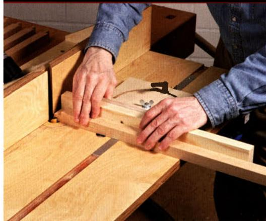
Den Queranschlag setzen Sie zusätzlich zum Längsanschlag immer dann ein, wenn Sie die kurze Kante des Werkstücks bearbeiten möchten, wie z. B. beim Anfräsen eines Zapfens oder Konterprofils. Aber auch wenn Sie einfach nur eine schmale Kante abrunden möchten, erleichtert der Queranschlag die Führung des Werkstücks.
