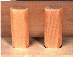
^ Links passend = 13,5 mm + Fräserdurchmesser
