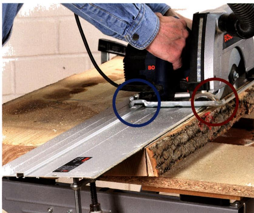
Pendelhaubsäge mit Führungsschiene
