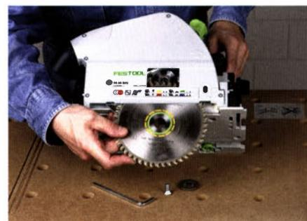
Entfernen Sie Schraube und Flansch und nehmen Sie anschließend das Sägeblatt heraus.
