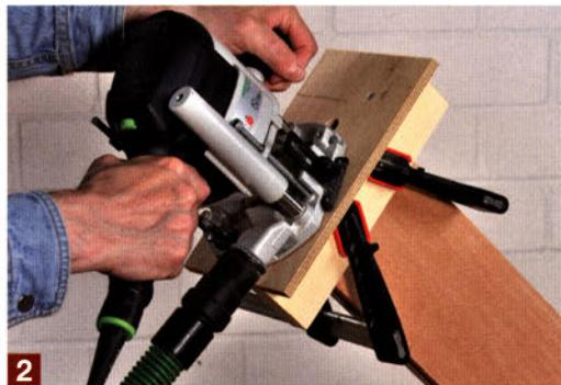
Für die stirnseitigen 10 mm Dübellöcher benutzen Sie am besten die Oberfräse zusammen mit einem langen 10er Nutfräser und einer Kopierhülse. Eine einfache selbst gebaute Schablone sorgt dann für genau senkrechte Dübellöcher.
