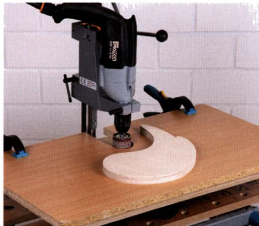
Nach dem Aussägen einer Kontur mit der Stichsäge müssen Sie in der Regel die Schnittkanten noch mal nacharbeiten. Das können Sie entweder mühsam von Hand mit Raspel, Feile und Schleifpapier oder ganz einfach mit der maschinellen Hilfe einer Bohrmaschine erledigen.
