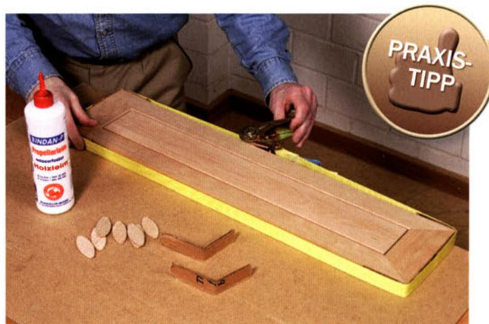
Etwas Leim, ein paar Flachdübel, ein Ratschenzuggurt und vier dicke Kartonstreifen als Eckenschoner reichen völlig aus, um einen auf Gehrung gefertigten Rahmen stabil und sauber zu verleimen. Ein Spanngurt sorgt dabei an allen vier Ecken für einen gleichmäßigen und optimalen Pressdruck.
