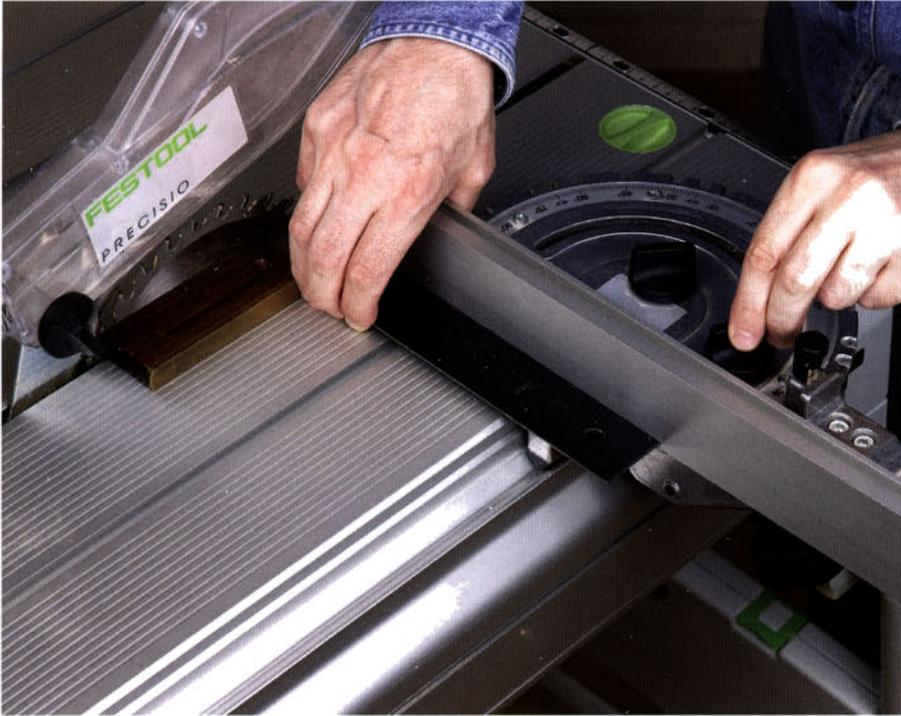
Vor dem Sägen sollten Sie mit einem hochwertigen Tischlerwinkel den rechten Winkel zwischen Sägeblatt und Anschlag kontrollieren.
