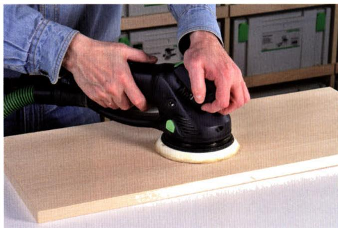
Den Getriebeexzentrerschleifer müssen Sie immer mit beiden Händen führen. Eine Hand umschließt das Motorgehäuse, während die andere den Schleifteller plan auf das Werkstück drückt. Beim Grobschliff oder Polieren können Sie – wenn nötig – noch einen Zusatzhandgriff links oder rechts am Tellergehäuse befestigen.
