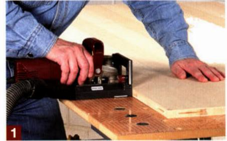
Über die Grundplatte bzw. den Gehäuseboden können Sie die Maschine besonders sicher und präzise ans Werkstück anlegen. Der Abstand vom Boden bis zur Dübelmitte ist dabei aber immer fest vorgegeben (in der Regel 10 mm).
