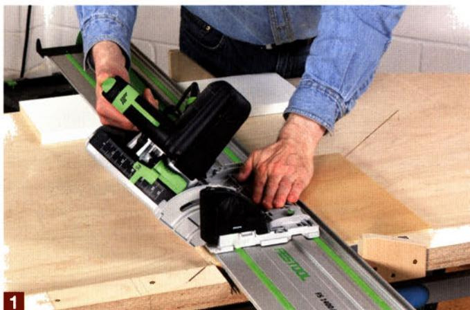
1 Schwenken Sie das Sägeblatt auf  $45^\circ$ . Legen Sie die Handkreissäge vor dem Werkstück auf die Führungsschiene und drücken Sie die Maschine während des gesamten Sägevorgangs fest mit der linken Hand auf die Führungsschiene.
