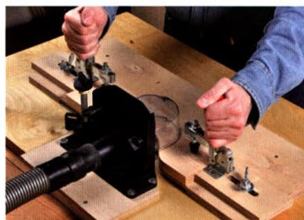
... ausgestattet, können auch unterschiedlich lange Werkstücke bearbeitet werden. Wenn Sie Schnellklemmen benutzen, bei denen die Griffe im geschlossenen Zustand nach oben zeigen, können Sie daran die Schablone ...
