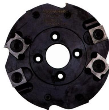
Fräser mit Wechselschneiden
