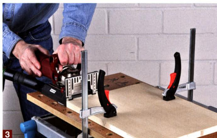
Die Außenseiten von Deckel und Boden flach auf das Brett legen, mit einer Zwin-gie fixieren und je zwei Schlitz-te in die Stirnkanten fräsen.
