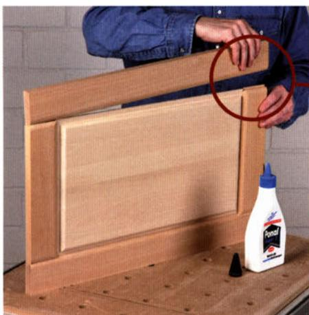
In den Rahmen kann man eine Massivholzfüllung einsetzen. Verleimt wird aber nur das Konterprofil und nicht die Füllung!
