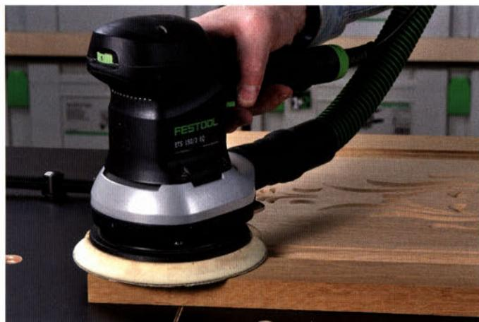
Führen Sie die Maschine nur mit mäßigem Druck und möglichst vollflächig aufliegend über das Werkstück. Achten Sie auch darauf, dass der Schleifteller nicht zu weit über die Werkstückkante hinaus bewegt wird. Dann liegt er nicht mehr voll auf und die Maschine kippt zur Seite weg. Dabei werden dann die Werkstückenden schräg geschliffen.
