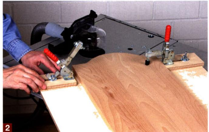
Bei unregelmäßigen Formen sollten Sie zur eigenen Sicherheit das Werkstück immer mit Schnellspannern auf der Schablone fixieren. Das geht nicht nur deutlich schneller als mit Nägeln, Schrauben oder Klebeband, sondern die weichen Druckkappen hinterlassen dabei auch keinerlei Macken und Beschädigungen auf dem wertvollen Holz.
