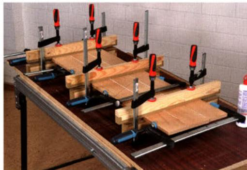
Die klassische Schraubzwinde ist aufgrund der enormen Spannkraft genau das Richtige um Leimholzplatten herzustellen.
