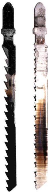
Wenn Sie beim Sägen zuviel seitlichen Druck auf das Sägeblatt ausüben – z. B. um wieder näher an eine Bleistiftmarkierung zu gelangen – entsteht an den Seiten des Sägeblatts eine sehr hohe Reibungswärme, die das Sägeblatt dunkel verfärbt. Der Sägeblattstahl verliert dabei an Härte und die Schärfe nimmt drastisch ab. Auch zu eng eingestellte Hartmetallführungen (-backen) können das Sägeblatt stark überhitzen.
