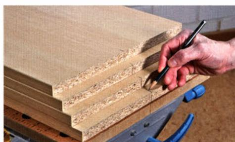
Für Werkstückbreiten bis ca. 25 cm reichen zwei Flachdübel pro Verbindung völlig aus. Darüber hinaus sollten Sie etwa alle 12 bis 15 cm einen weiteren Flachdübel einfräsen. Legen Sie dazu alle Bretter auf einen Stapel, zeichnen Sie sich die Mitte der Flachdübel mit einem Winkel an die Brettkannte (links) und übertragen Sie anschließend den Riss auf die Holzfläche (rechts).
