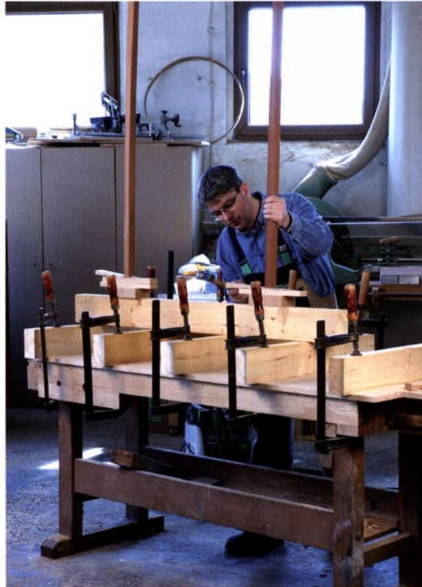
In schwierigen Fällen können Sie auch die Werkstattdecke als „Druckmittel“ einsetzen: Ein paar dicke Streben gegen die Decke gekeilt und großdi- mensionierte Balken als Zula- ge und Druckverteilung für die Plattenmitte.
