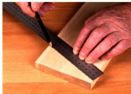
Zum präzisen Anzeichnen und Anreißen sind die Stahlmaßstäbe mit ihrer Halbmillimeter-Teilung genau das Richtige. Eine matte Metalloberfläche mit eingravierten Skalen sorgt bei teuren Modellen zudem für ein blendfreies Ablesen der Maße.
