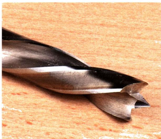
Durch die spezielle Spitzegeometrie des FCE-Professional-Bohrers ergeben sich beim Durchbohren eines Werkstücks keine Ausrisse auf der Rückseite. Dadurch spart man enorm viel Zeit, weil bei diesen Bohrern erstmals keine Unterlage eines Restholzes benötigt wird (Bohrer-Sets ab 35 Euro erhältlich).
