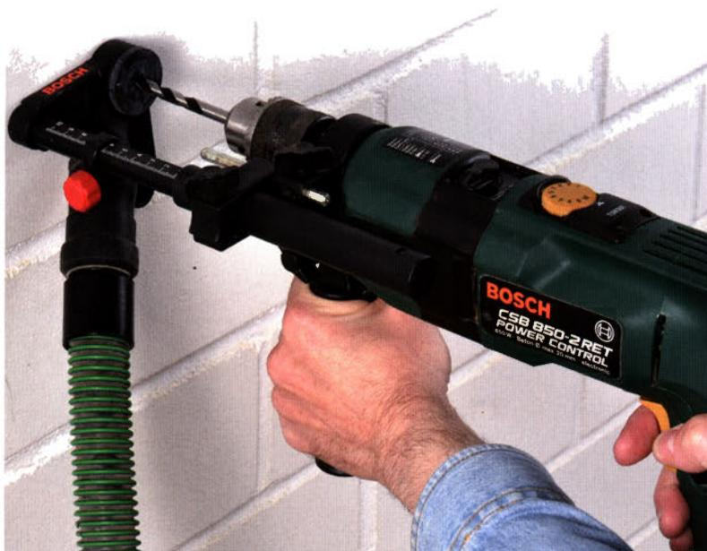
Der Traum aller Hausmänner und -frauen: Löcher bohren ohne Staub. Das gelingt am besten mit einer speziellen Staubabsaugung direkt im Bereich des Bohrers bzw. Bohrlochs. Dort wird fast der gesamte Staub über einen angeschlossenen Sauger aktiv abgesaugt.
