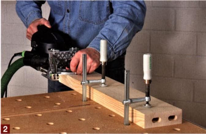
von 70 mm ein. Dann den Anschlagstift dicht ans Rahmenteil anlegen und das erste Dübelloch fräsen. Anschließend den Stift seitlich ins Dübelloch anlegen und mit diesem Rasterband das zweite Loch fräsen.
