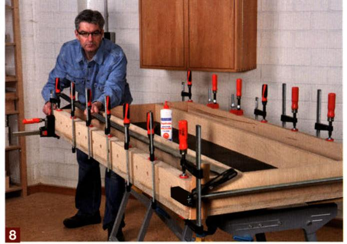
Zum Schluss leimen Sie dann auch nacheinander die beiden langen Außenzargen (die mit den Löchern ist auf 50 mm Dicke aufgedoppelt s. a. Bild 7) auf die Tischfläche.
