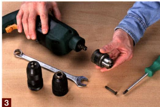
Zuerst das Bohrfutter einfach mithilfe des Maulschlüssels und des eingesteckten Zahnkranzschlüssels wieder festziehen. Zum Schluss die Schraube mit Linksgewinde wieder eindrehen.
