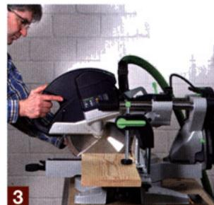
3 In dieser Position Sägeblatt auf den Führungsstangen zurückschieben
