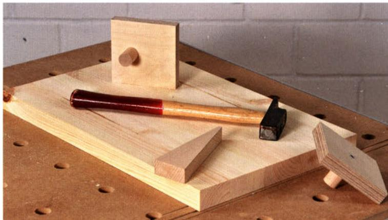
Diese selbstgebauten Spannenteile bestehen aus einem 100 mm großen, quadratische Spannplättchen aus 15 bis 18 mm dickem Multiplexholz. Darunter wird ein Buchen-Rundstab ( $\varnothing$  20 mm, Länge ca. 30 mm) außermittig geleimt und verschraubt. Der Rundstab greift später in eine gelochte Platte (Lochraster 96 x 96 mm, Lochdurchmesser 20 mm).
