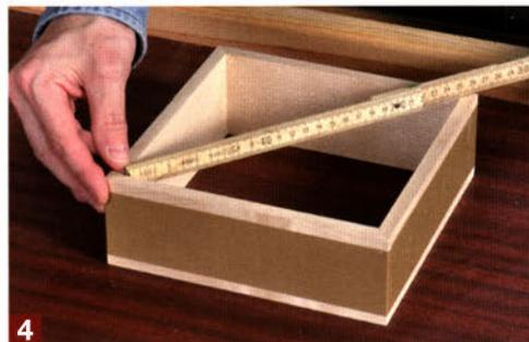
Gehrungen zu einem Kasten zusammen. Spannen Sie das Klebeband möglichst straff über die letzte Gehrung, um einen hohen Pressdruck und geschlossene Gehrungen zu erhalten (Bild 3). Zum Schluss kontrollieren Sie über die Diagonalmessung (Stichmaß), ob der Kasten auch im rechten Winkel ist (Bild 4 und s. a. Infos auf Seite 58 – Winkelkontrolle).
