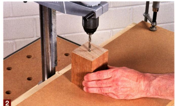
Werkstück mit dem gebohrten Loch auf den Dübel stecken und die Gegenseite bohren.
