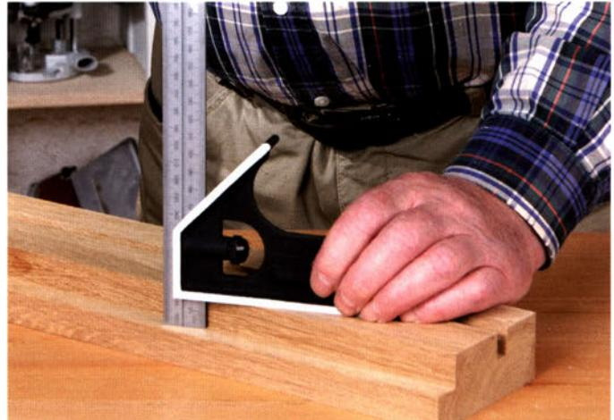
4. Anschlag auflegen, Stahllineal nach unten schieben und schon können Nuten oder Zapfenlöcher nachgemessen werden.
