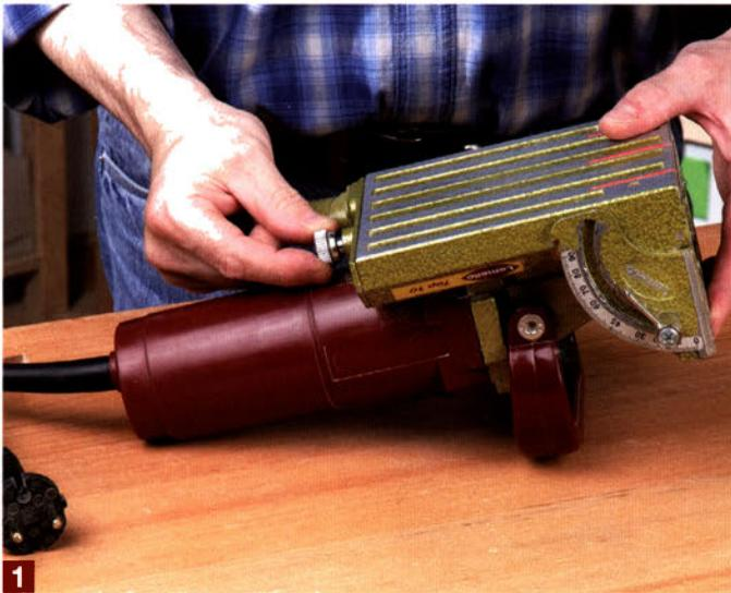
**1** Bei hochwertigen Maschinen muss lediglich eine Schraube gelöst werden, dann lässt sich der Metallanschlag nach vorne herausziehen.
