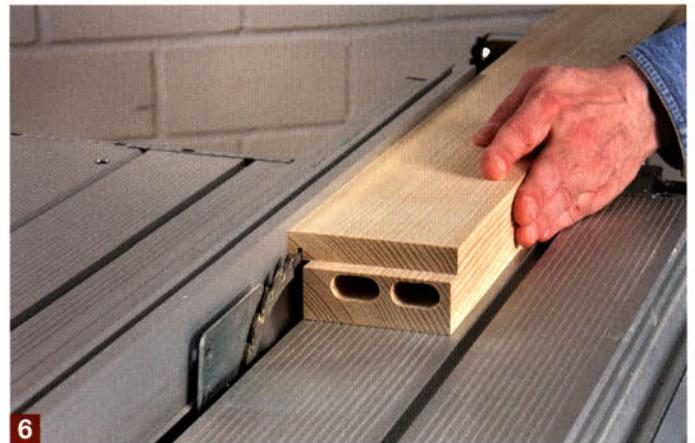
**6** Die Nut für die Tü rdichtung können Sie am einfachsten auf der Tischkreissäge mit einem ca. 3 mm dicken Sägeblatt herstellen.
