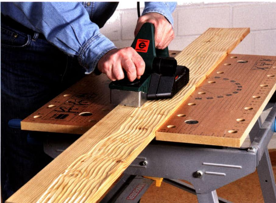
Zum Glätten und Strukturieren von rohen Brettern und Balken ist der Elektrohobbel sehr gut geeignet. Aber die Präzision einer stationären Hobelmaschine kann er niemals erreichen.
