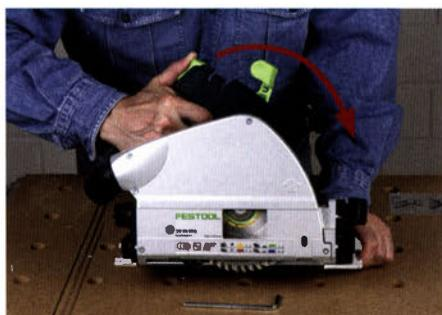
... als auch das Sägeblatt in der richtigen Position im Gehäuse fixiert (dazu Säge entriegeln und nach unten drücken bis sie einrastet).
