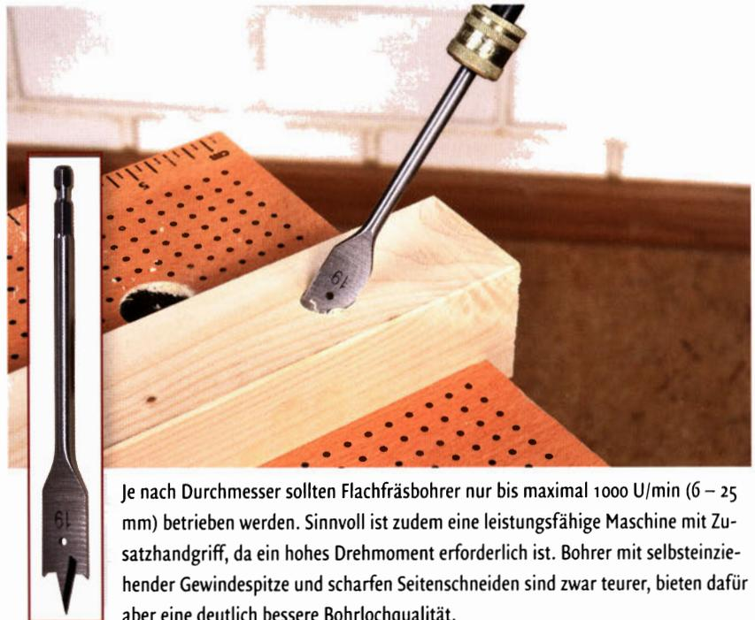
Je nach Durchmesser sollten Flachfräsbohrer nur bis maximal 1000 U/min (6 – 25 mm) betrieben werden. Sinnvoll ist zudem eine leistungsfähige Maschine mit Zusatzhandgriff, da ein hohes Drehmoment erforderlich ist. Bohrer mit selbsteinziehender Gewindespitze und scharfen Seitenschneiden sind zwar teurer, bieten dafür aber eine deutlich bessere Bohrlochqualität.
