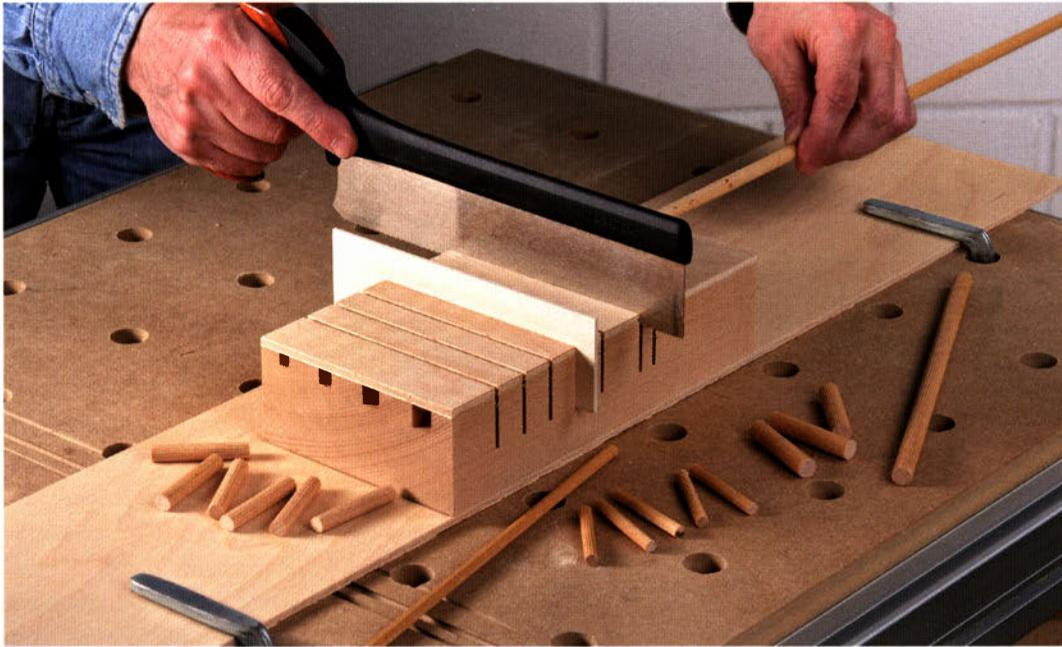
Wenn Sie keine Kappsäge-/ Kappzugsäge besitzen oder wenn Sie nur wenige Dübel benötigen, können Sie die Dübelbox auch schnell und einfach mit einer normalen Handsäge benutzen.
