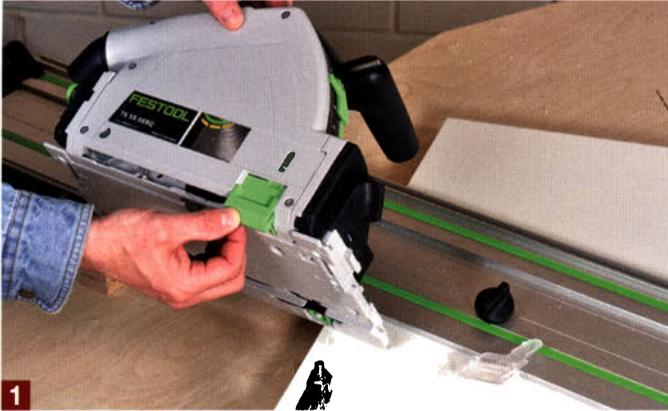
Wenn Sie bei beschichteten Platten den Teil vom Werkstück benötigen, der sich außen neben der Säge befindet, dann sollten Sie noch den Ausreisschutz montieren.
