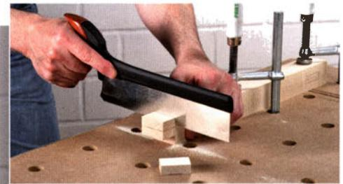
Bei einer Rückensäge wird das Sägeblatt nach oben hin durch einen „Rücken“ versteift. Sie ist dadurch deutlich stabiler und hält besser die Spur. Kleinere Modelle eignen sich sowohl zum Sägen von Zinken und Schwalbenschwänzen, als auch zum Sägen von Zapfenverbindungen (Fa. Veritas ca. 47 Euro).
