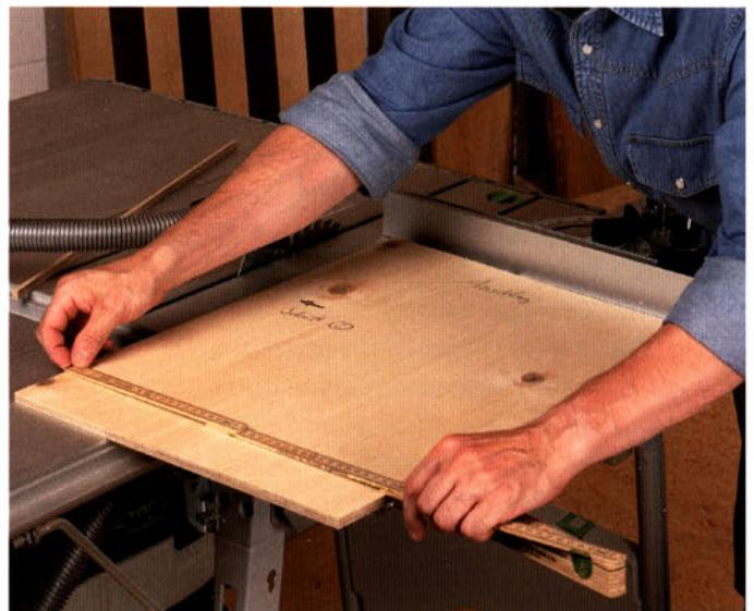
Messen Sie anschließend die vordere und hintere Plattenkante nach. Sind die Maße identisch, ist der Anschlag perfekt rechtwinklig zum Sägeblatt eingestellt.
