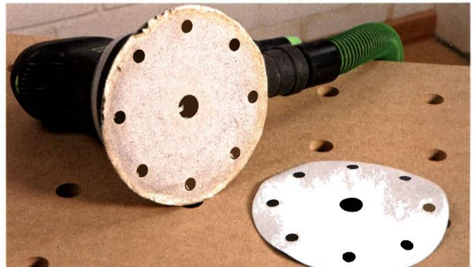
**Stumpfes Papier** frühzeitig wechseln sonst werden durch „eingebrannte“ Holzfasern und Staub nur zusätzliche Riefen in die Oberfläche geschliffen. Wichtig: Mit geringem Druck, vollflächig und nicht mit den Kanten des Schleiftellers arbeiten!
