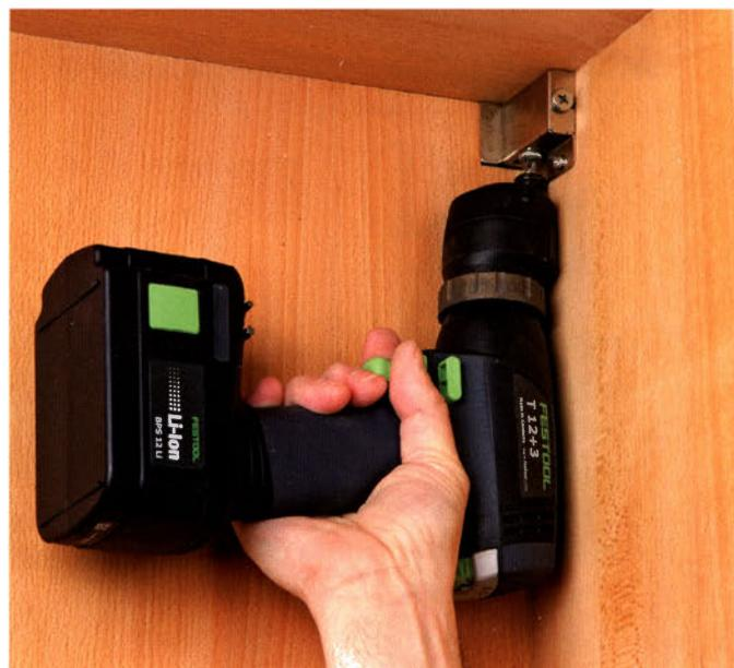
Ein Exzentervorsatz (Fa. Festool) ist auf den ersten Blick ein recht unscheinbares Zubehör, aber zum randnahen Schrauben oder Bohren oft die einzige Möglichkeit. Dies wird durch den nach außen angeordneten Bithalter erreicht. Den Vorsatz samt Bithalter kann man zusätzlich um 360° drehen und so die bestmögliche Arbeitsposition für die jeweilige Anwendungssituation einstellen.
