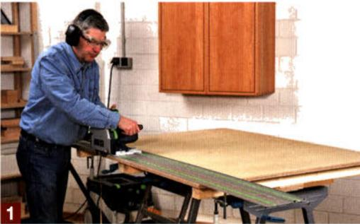
1 Die Platte vollflächig auf ausreichend viele Böcke oder Balken auflegen und zunächst nur eine schnurgerade Bezugs-kante an eine Plattenseite sägen.
