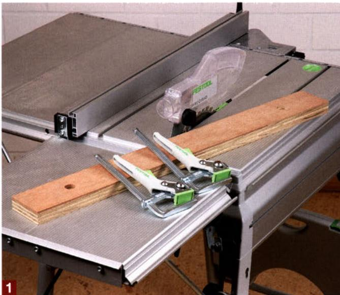
Alles was Sie neben einer Tischkreissäge dazu benötigen, ist eine ca. 80 mm breite und 20–25 mm dicke Holzleiste (z. B. Multiplex-Birke) in der Länge des Längsanschlags. In diese Holzleiste bohren Sie 100 mm vom Ende je ein 25 mm großes Loch, in das Sie später je eine Zwinne einstecken.
