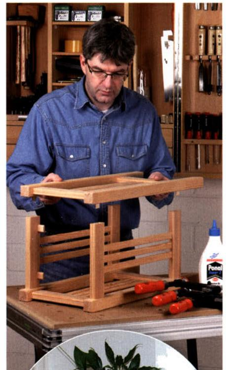
Besonders im Gestellbau bei kleinen Leistenquerschnitten kann der Domino seine Stärken ausspielen. Ein Flachdübel wäre zu groß und nur ein Runddübel würde für eine verdrehsichere Verbindung nicht ausreichen. Aber schon der kleinste Domino mit nur 5 x 18 mm Querschnitt hält Zargen und Pfosten dieses Blumenständers bombenfest zusammen. Dabei dauert das Fräsen aller Verbindungen nicht mal 15 Minuten!
