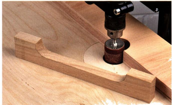
... den Auslegerarm den gewünschten Überstand der Hülse zur Anschlagkante ein und schieben Sie das mit der Stichsäge grob zugesägte Werkstück am Anschlag vorbei.
