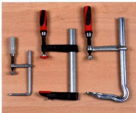
Schraubzwingen erzeugen den Druck über eine Gewindespindel. Die Spannkraft lässt sich mit dem Gewinde sehr gut dosieren.
