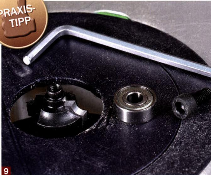
Die Kante der Füllung wird dann noch mit dem Abrundfräser (R 3 mm) gerundet. Dazu müssen Sie aber zunächst das Kugellager vom Fräser abmontieren, weil es sonst beim Fräsen auf der Abplattung aufliegen würde. Dann können Sie bequem auf dem Frästisch die Füllungskante abrunden. Auch die Innenkanten des Rahmens werden 3 mm abgerundet.
