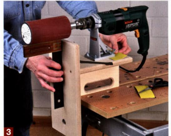
Nachdem Sie die Bohrmaschine samt Schleifhülse im Spannbock befestigt haben, überprüfen Sie mit einem Winkel die Rechtwinkligkeit zwischen Hülse und Grundplatte. Mit dünnem Papier (hier dünnem Schleifpapier) das Sie unter den Aufspannbock legen, können Sie die Rechtwinkligkeit wenn nötig sehr präzise nachjustieren.
