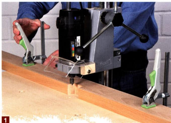
**1** Zum Falzen muss die Anschlagleiste in der Mitte eine Auskerbung für den Fräser besitzen. Befestigt wird der Anschlag einfach mit zwei Zwingen auf der Tischplatte.
