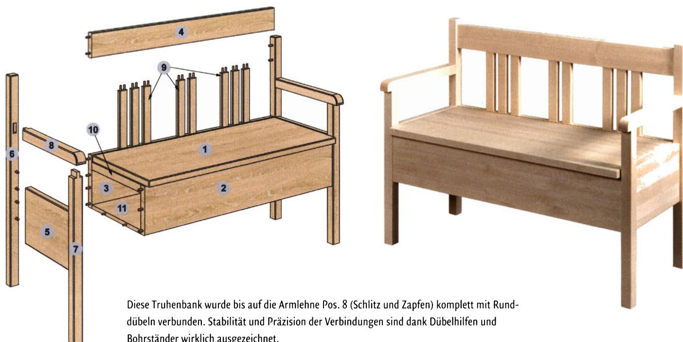
Diese Truhebank wurde bis auf die Armlehne Pos. 8 (Schlitz und Zapfen) komplett mit Runddübeln verbunden. Stabilität und Präzision der Verbindungen sind dank Dübelhilfen und Bohrständer wirklich ausgezeichnet.
