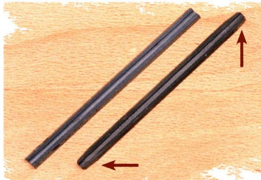
Zum Hobeln von großen Flächen gibt es spezielle Hartmetall-Wendemesser mit abgechrägten Enden (Pfeile), die im Gegensatz zu den normalen Wendemessern keine Hobelansätze auf der Fläche hinterlassen. Eine Nut in den Wendemessern sorgt für eine immer gleichbleibende Position der Messer im Träger.
