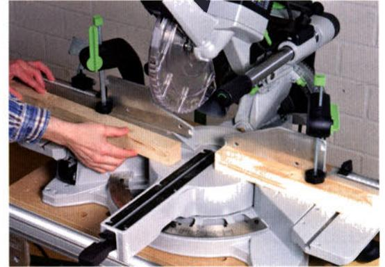
Je nach Werkstückdicke oder Kapptiefe müssen Sie bei diesen Anwendungen aber den Anschlag mit dickeren Leisten oder Brettern etwas auffüttern. Ohne diese Leisten würde die Nut im hinteren Anschlagbereich nicht tief genug bzw. bogenförmig nach oben hin auslaufen. Auch die Dicke bzw. Stärke der Auffütterung muss der Werkstückdicke und Kapptiefe entsprechend angepasst werden.
