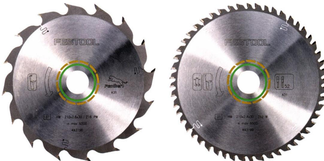
Links: Sägeblatt mit nur 16 Zähnen und großem Spanraum für schnelles Sägen mit weniger Kraft besonders beim Längsschnitt von Massivholz (Hart- oder Weichholz)
