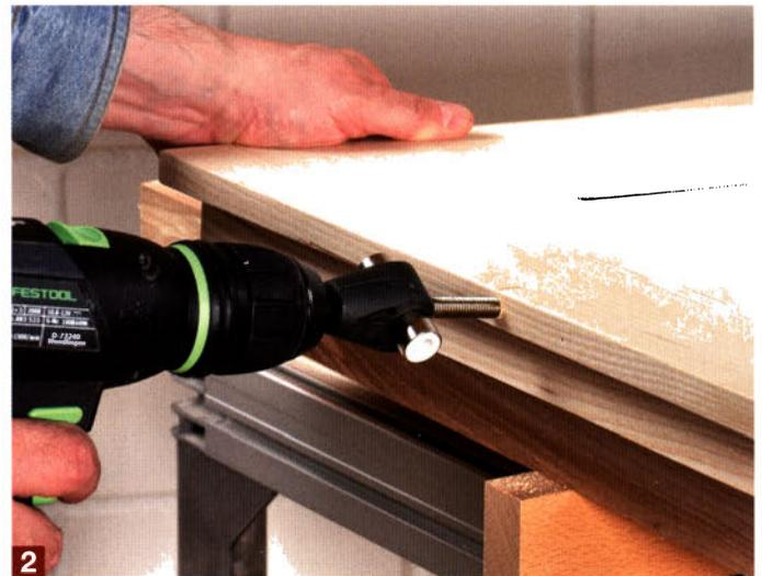
Im Set mit der Bohrlehre und dem passenden Stufenbohrer befindet sich auch ein Hakeneindreher, der genau zum Rollendurchmesser der Bänder passt. Damit lassen sich die einzelnen Einbohrteile im Handumdrehen bequem mit einem Akkuschrauber ins Holz eindrehen.
