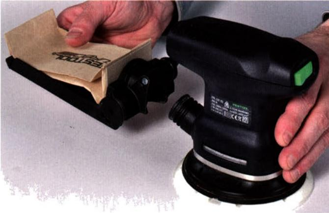
Auch wenn fast alle Geräte mit einem passenden Staubsack geliefert werden, sollten Sie möglichst immer mit einer aktiven Staubabsaugung in Form eines leistungsfähigen Werkstattsaugers arbeiten (s. dazu auch S. 338).
