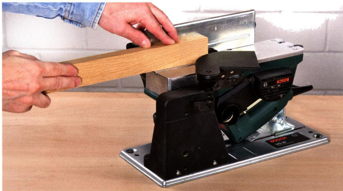
Während Sie die Leiste über die vordere Hobelsohle schieben, wird der Messerschutz durch die Leiste automatisch zur Seite geschwenkt und gibt nur den für die Leiste benötigten Hobelbereich frei. Am Ende der Leiste schwenkt sich der Messerschutz durch die integrierte Feder wieder zurück bis zum Winkelanschlag.
