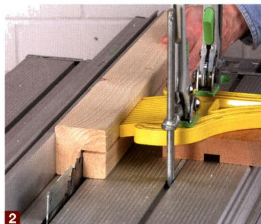
Stellen Sie die Sägeblatthöhe auf die gewünschte Falztiefe ein und befestigen Sie ca. 30 – 50 mm vor dem Sägeblatt eine Andruckfeder. Der zweite Sägeschnitt muss so gewählt werden, dass das Reststück nach rechts außen abfällt und nicht zwischen Parallelanschlag und Sägeblatt.
