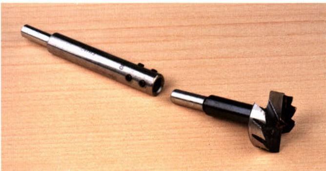
Die Bohrerverlängerung der Fa. Famag gibt es in drei Ausführungen passend für 8, 10 und 13 mm Bohrerstäbe und kann daher auch problemlos bei Fremdfabrikaten eingesetzt werden. Der Schaft wird einfach eingesteckt und mit den vier Inbusschrauben in der Verlängerung gesichert.
