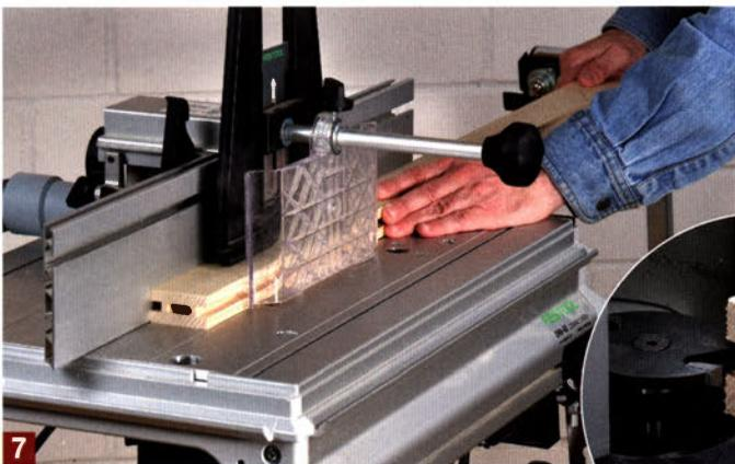
In die Sprossen und Türrahmenfrieze fräsen Sie mit einem Scheibennutfräser eine 9,5 mm tiefe und 8 mm hohe Nut ein.
