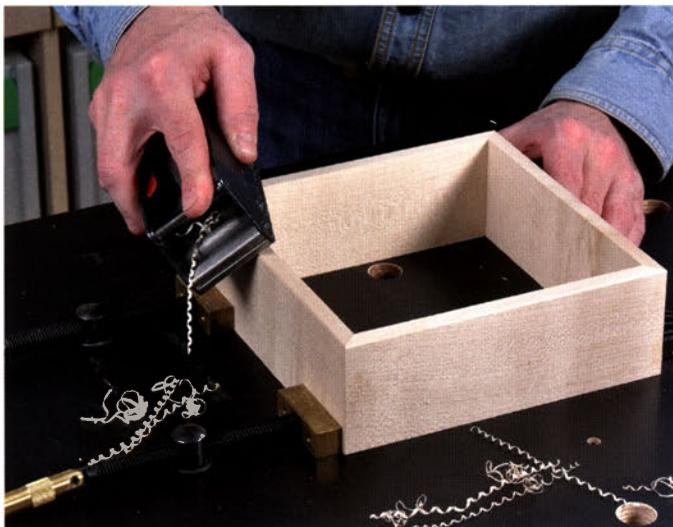
Ein handlicher Block- bzw. Einhandhobel gehört in jede Holzwerkstatt und wird dort schnell zum Handwerkzeug, das Sie am häufigsten einsetzen werden. Zum Anschärfen von Brettanten gibt es keine schnellere Alternative.
