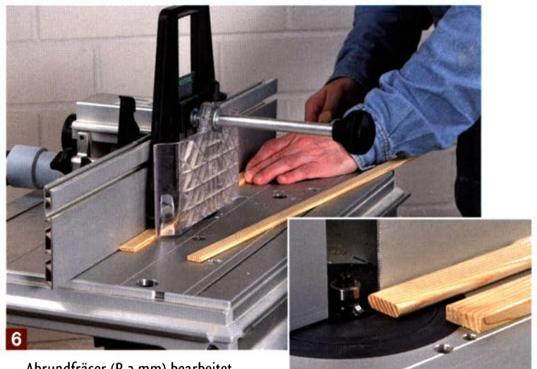
6 ... Abrundfräser (R 3 mm) bearbeitet, dabei entsteht dann der Querschnitt eines 6-mm-Dominos. Auf dem Frästisch unbedingt zwei Andruckvorrichtungen benutzen!
