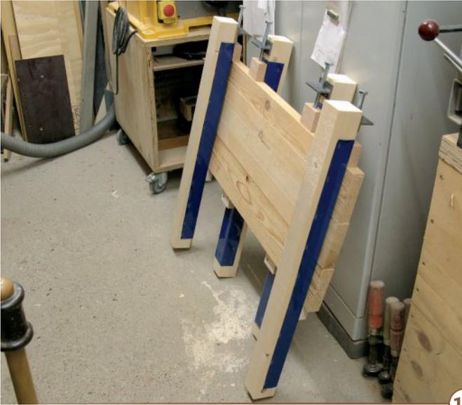
Während der Leim abbindet, kann die ganze Vorrichtung beiseite gestellt werden, und die Hobelbank ist frei für weitere Arbeiten.
