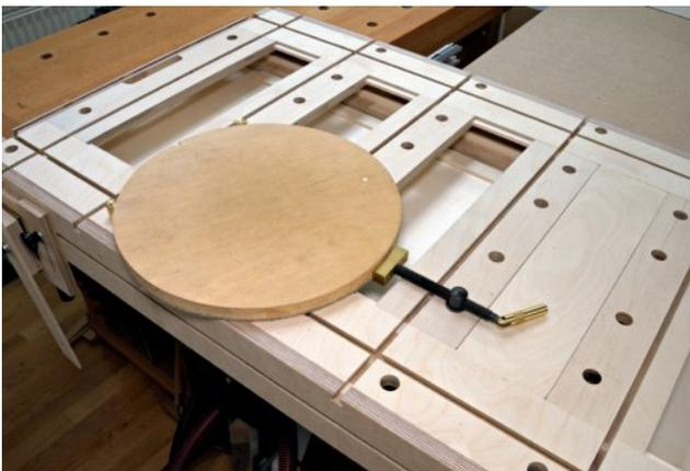
**Anwendungsmöglichkeit 3**: Mit den Veritas-Spannzangen Werkstücke wie auf einer Hobelbank einspannen, unabhängig von der Form der Werkstücke. Lose Tischeinlagen schließen die Zwischenräume der Querbretter, wenn eine geschlossene Arbeitsfläche gewünscht wird.
