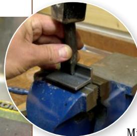
Mit einem Körner 25 mm von der Außenkante und in der Mitte des Abschnitts den Bohrmittelpunkt markieren (kleines Bild). Das 8,5 mm-Kernloch für das Gewinde wird zunächst kleiner mit etwa 3,5 mm vorgebohrt. Schneidöl schont dabei den Bohrer.
