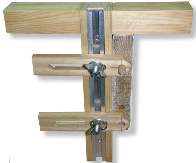
So können Sie sehr schnell die neuen Dübellöcher anfertigen: Dübellehre aufspannen, erstes Loch bohren, Holzdübel in die obere Zunge stecken, unteres Loch bohren – fertig. Der kleine Winkel unten im Bild hilft, wenn man einen Dübel auf gleicher Ebene versetzen muss.
