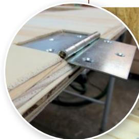
Ein Parallelanschlag ist auch beim freihändigen Fräsen wie hier für die Scharniertaschen eine gute Hilfe. Er verhindert, dass die Ausfräsungen zu breit werden. Gut zu sehen:
