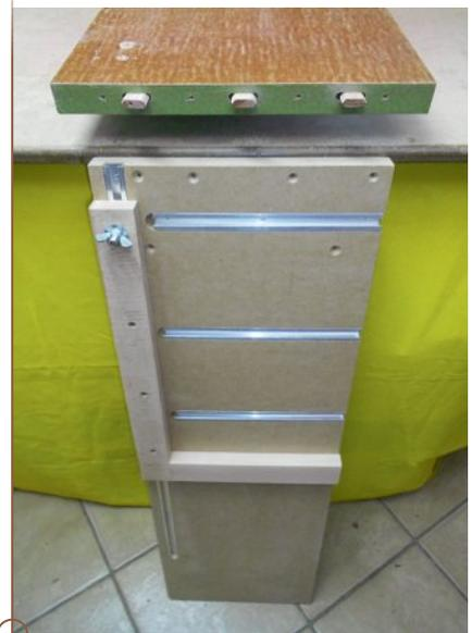
Die Platten sind über Dominodübel und Schrauben winklig miteinander verbunden. Die aufrechte T-Nut-Schiene trägt das L-förmige Haltestück, das ein Durchrutschen des Werkstücks verhindert.
