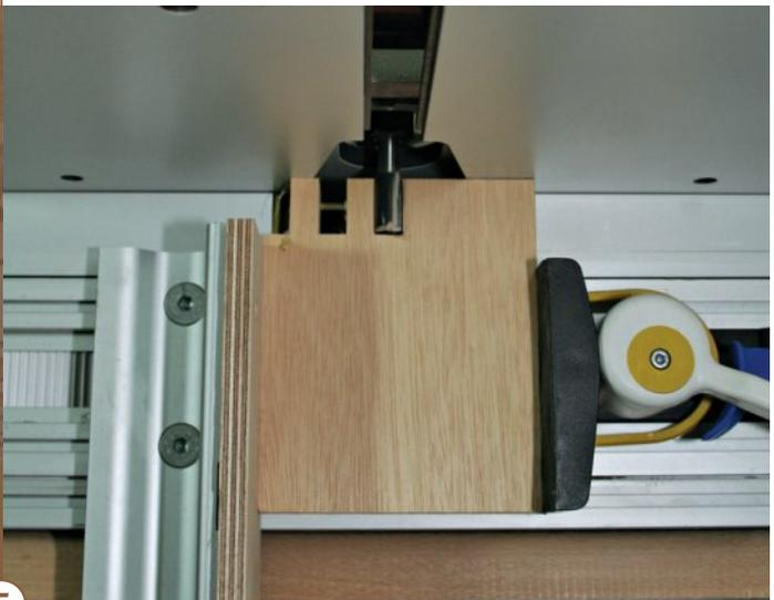
So lassen sich Werkstücke kopieren beziehungsweise die passenden Gegenstücke fertigen: Das genaue Fräserbild wird einmal an der Spannvorrichtung (links) markiert und dann durch den Fräser (rechts) übertragen.
