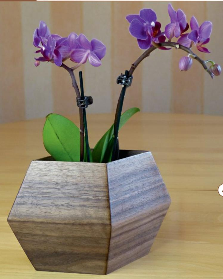
Unser erstes Anwendungsbeispiel: An dieser Blumenvase sind einige Winkel über  $45^\circ$  und auch sehr flache Winkel. Beides kann mit der  $45^\circ$ -Rampe auf der Tischkreissäge geschnitten werden.
