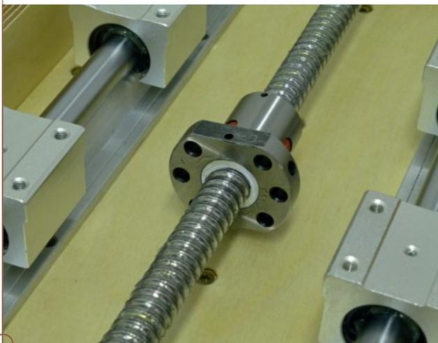
Kugelumlaufmuttern wie diese in der Mitte und Gleitlager auf Schienen (links und rechts am Bildrand) verwandeln die Drehung der Schrittmotoren in Vorschub für die betreffende Achse.
