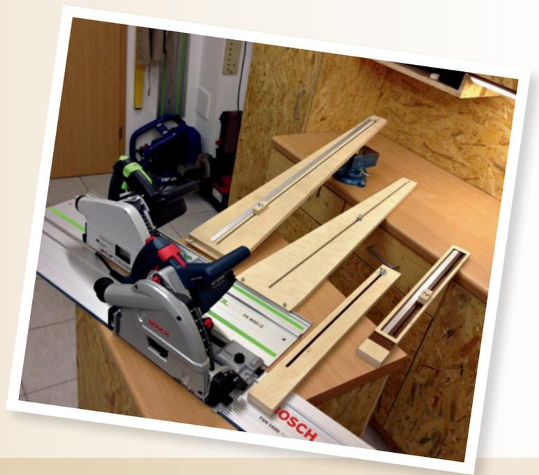
**D**ie handliche Tauchkreissäge ist in Verbindung mit einer Führungsschiene äußerst vielseitig und die Schnitte werden sauber und exakt. Ein Zuschnittbrett ist ein bekanntes und hilfreiches Zubehör für Schnitte in kleinere Werkstücke. Auch lassen sich damit lange schmale Teile ablängen.
