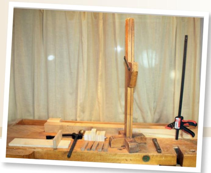
**D**ie Vorderzange übernimmt durch ihre breite Spannfläche die meisten spannenden Aufgaben an der Hobelbank. Das Werkstück sollte möglichst kurz eingespannt werden: Die zu bearbeitende Seite steht nur so weit wie nötig über die Bankzange über, damit das Werkstück nicht vibriert. Die Belastung sollte beim Bearbeiten senkrecht zu den Spannflächen gehen. Das Werkstück kann so nicht kippen, selbst wenn Kraft darauf ausgeübt wird.
