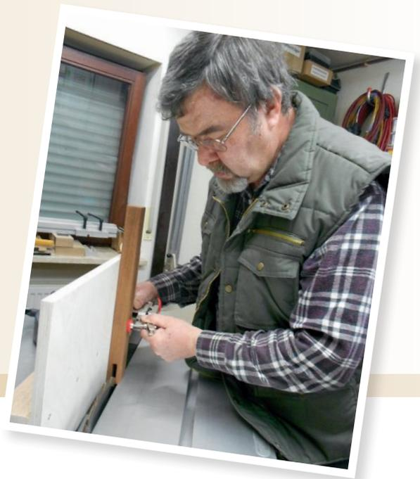
**F**ür meine recht große Tischkreissäge habe ich mir einen Schlitten gebaut, da ich eine 16 Quadratmeter kleine Werkstatt habe. Ich müsste den Ablänganschlag meiner Kreissäge mit 1,3 Meter Länge jedes Mal montieren, um etwas zu sägen. Aber auch für sehr kleine Sägen kommt die Vorrichtung zupass. Der Ablängschlitten kommt einfach in die Nut des Schiebeschlittens der Kreissäge und schon kann man ein kleines bis mittleres Werkstück bearbeiten.
