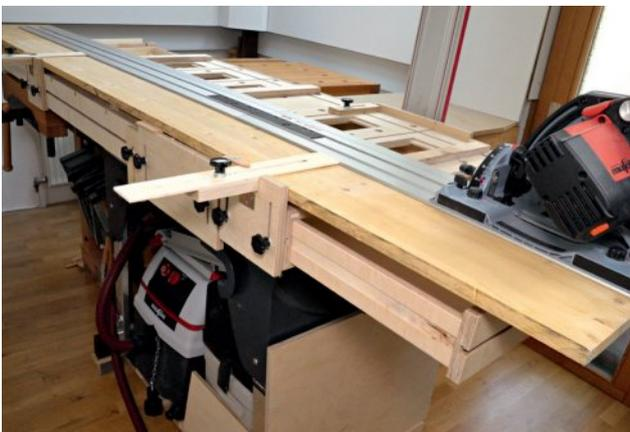
**Anwendungsmöglichkeit 1**, auf Breite sägen: Beide Klappanschläge auf gleiche Länge einstellen. Die linke Brettkante an die Halterungen der Klappanschläge und die Führungsschiene an die Zungen der Klappanschläge legen. Die Schubkästen dienen als Auflage. Das Werkstück liegt auf Distanzleisten.
