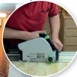
Am einfachsten gelingt das Heraustrennen des Mittelteils mit der Tauchsäge und einer Führungsschiene. Zeichnen Sie sich die Schnittposition genau an und arbeiten Sie nach Anriss.
