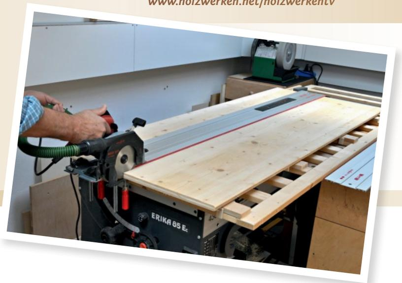
**D**ie Idee zum selbstgebauten Multifunktions-Tischaufsatz (Mufta) entstand aus dem nicht mehr benötigten Gitter eines Kinderbettes (kleines Bild oben rechts). Es wurde auf die kleine Tischkreissäge aufgelegt und diente als Arbeitsunterlage zum Sägen mit Handkreissäge und Führungsschiene großer Teile. Doch die Wiederholgenauigkeit beim Ablängen und auf Breite Sägen war unbefriedigend. Das Gitter musste optimiert werden. Das sind die Vorteile der neuen Konstruktion:
