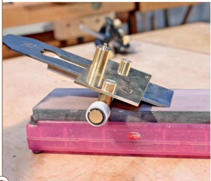
Ein einfacher Holzanschlag legt fest, wie weit das Werkzeug aus der Schleifführung ragen kann. So liefert jeder Anschlag einen fest definierten Winkel, der gut sichtbar notiert wird.
