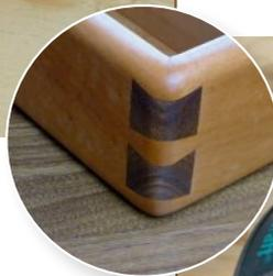
Die falschen Zinken werden auf der Tischkreissäge passgenau geschnitten und in die Fräsungen geleimt. Auch hier kann Holzkontrast die Eckverbindung hervorheben. Nach dem bündigen Abschneiden der Überstände haben Sie eine stabile und dekorative Eckverbindung.
