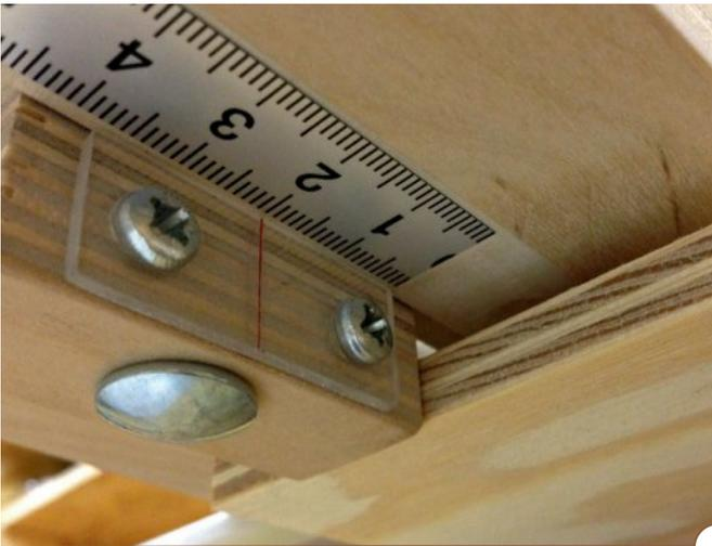
Sind die Anschlagschienen in Position, wird die Führungsschiene verschoben, bis die Anschläge am Werkstück anliegen. Die Anschlagschienen sollten weit außen aufgelegt werden. So kann die Führungsschiene genau ausgerichtet werden.
