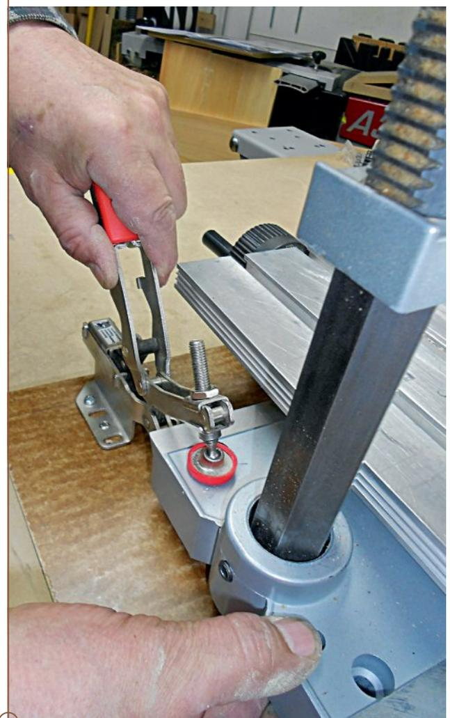
Der Bohrständler wird frei über die Tischplatte bewegt. Steht die Bohrerspitze über dem angezeichneten Bohrpunkt, rasten die Kniehebelspanner ein.
