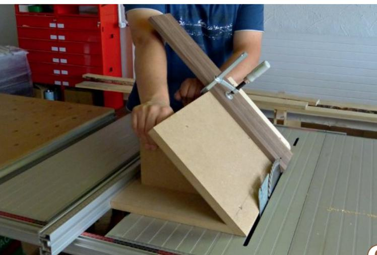
Das Werkstück wird durch die Rampe auf  $45^\circ$  zur Tischebene angehoben. Durch Neigen des Sägeblattes können nun Winkel jenseits von  $45^\circ$  problemlos geschnitten werden. Die Vorrichtung wird samt aufgespanntem Werkstück am Parallelanschlag entlang geführt. Sie selbst können weit außerhalb des Gefahrenbereiches stehen, die Hände sind weit vom Sägeblatt entfernt.
