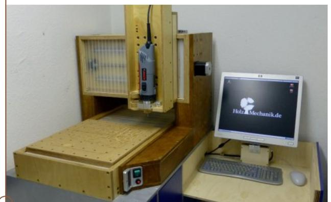
Der Solidis-Arbeitsplatz inklusive PC passt in eine kleine Ecke. Blasius empfiehlt, für die Maschine einen eigenen Steuerungsrechner zu betreiben, der mit dem Betriebssystem Linux ausgestattet ist.
