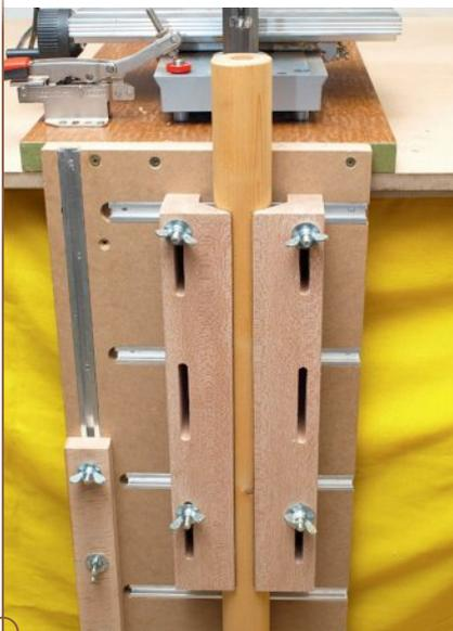
Passend für die jeweiligen Werkstücke angefertigte Halter sind empfehlenswert für exakte Bohrergebnisse.
