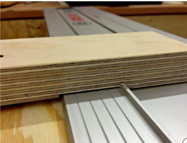
Die Maßanschlagschiene wird einfach auf das Profil der Führungsschiene gesteckt.
