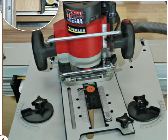
Während die Schwalben mit einem entsprechenden Fräser gefräst werden (kleines Bild), gibt beim Zinken eine von zwei drehbaren Schnecken (die „Spiralen“) vor, in welchem Winkel die Fräse durchs Holz geht.
