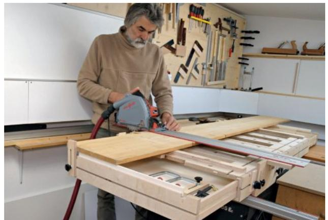
**Anwendungsmöglichkeit 2**, ablängen mehrerer kurzer Bretter: Brettlänge am Werkstück markieren, die Linie an die Schnittfuge der vorderen Führungsschienen-Halterung legen. Anschlagklotz als Längenanschlag in die T-Nut der Schubkastenblende anschrauben.
