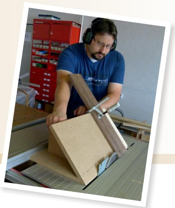
**D**iese einfache Vorrichtung erlaubt es, Schnitte weit jenseits von 45° auszuführen, falsche Federn einzusetzen oder flache Zinken herzustellen. Die kleine Rampe kann längs und quer zu Sägeblatt oder Fräser geführt werden und erhöht ihre Einsatzbereitschaft noch weiter. Anhand dreier Beispiele zeigen wir Ihnen, was man mit diesem einfach zu bauenden Helfer so alles machen kann. Sicherlich fallen Ihnen aber noch weitere Möglichkeiten ein.
