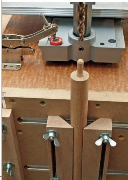
Das exakte Dübeln von Rundstäben an der Hirnseite ist mit der Eigenbau-Vorrichtung kein Problem mehr.
