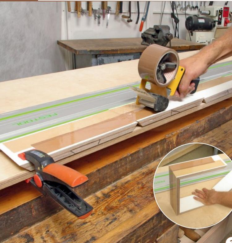
Paketklebebandmethode: Dazu werden die spitzen Enden etwa vier Millimeter weit übereinander gelegt, die Leimflächen bestrichen und dann zusammengeklappt.
