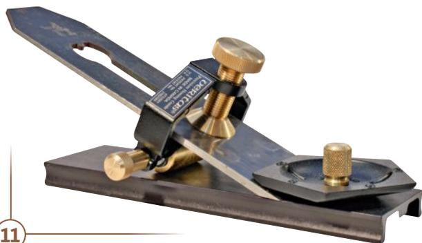
Mikrofasen sind bereits bei der einfacheren Veritas-Führung kein Problem. Die exzentrisch gelagerte Führungsrolle ermöglicht das.
