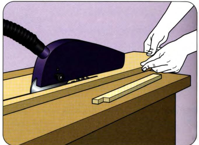
**1** Um gute Leistungen zu erhalten, sollte man die Anschaffung von speziellen Sägen für Schnitte mit der Faser (auf Breite) und quer zu ihr (auf Länge) in Betracht ziehen. Sie sind für diese Schnitte optimiert und schneiden deshalb wirkungsvoller.
