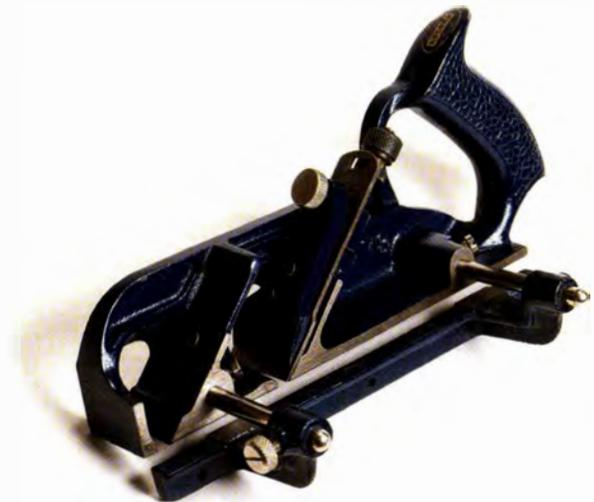
Der Wandungshobel ist ein einzigartiges Werkzeug, mit dem die Wandung eines Falzes oder einer Nut bearbeitet werden kann, um Verbindungen etwa bei Rahmen- und Füllung-Konstruktionen nachzuarbeiten.
