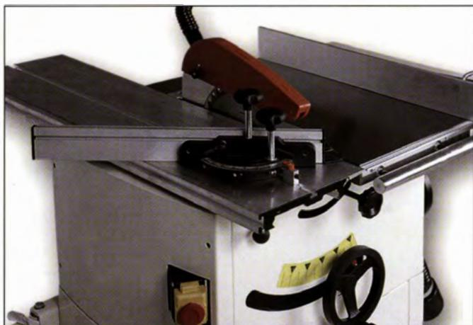
Platten zuzuschneiden und lange Bretter abzulängen. Er wird an der linken Seite der Maschine angebracht und bietet mehr Unterstützung für das Material als ein Schiebetisch, benötigt allerdings auch mehr Platz.
