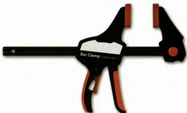
Die Einhandzwinge funktioniert wie eine Kartuschenpresse, man kann sie also mit einer Hand ansetzen und anziehen. Die Zwinge besteht aus Stahl, an den Backen sind Kunststoffauflagen angebracht, um das Werkstück zu schützen. Einhandzwingen sind ideal, um Holz an einer Klappwerkbank festzuspannen.
