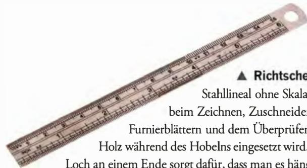
▲ **Richtscheit** Ein Stahllineal ohne Skala, das beim Zeichnen, Zuschneiden von Furnierblättern und dem Überprüfen von Holz während des Hobelns eingesetzt wird. Ein Loch an einem Ende sorgt dafür, dass man es hängend an der Wand aufbewahren kann.
