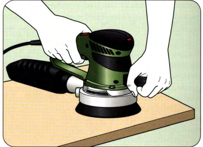
**1** Beginnen Sie mit einer 80er Körnung, und schleifen Sie abschließend mit einer 120er Körnung mit der Faser. Falls die Oberfläche bereits eben ist, kann dieser Schritt entfallen, und man kann mit Schritt 2 beginnen, wobei man einen Schwing- oder Exzentrerschleifer mit Papier in einer 120er Körnung einsetzt.
