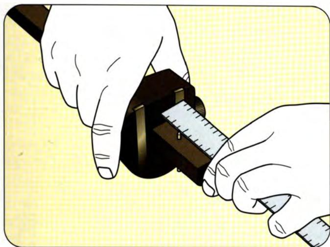
**1** Stellen Sie mit dem Stahllineal das Streichmaß auf die gewünschte Entfernung ein, und ziehen Sie dann die Feststellschraube an. Kontrollieren Sie das Maß, falls es nachgestellt werden muss, lockern Sie die Schraube leicht, und klopfen Sie mit dem Schenkel des Streichmaßes auf die Hobelbank. Wenn das Maß richtig eingestellt ist, ziehen Sie die Feststellschraube wieder an. Ein Streichmaß mit Messer wird auf die gleiche Weise eingestellt.
