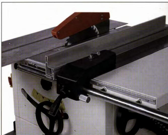
knapp hinter das Sägeblatt anliegen muss, um Klemmen am Blatt zu verhindern. Aus diesem Grund sollte der Anschlag mit einer entsprechenden Anlage versehen sein, die sich dem zu bearbeitenden Material entsprechend verstellen lässt.
