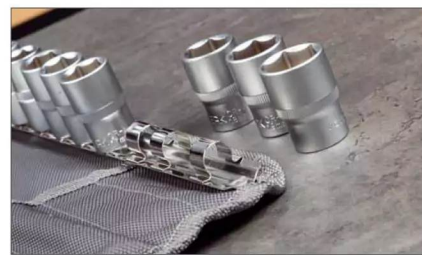
Die Nüsse werden mit dem Vierkant auf die Schiene gesteckt und bleiben so sauber fixiert
