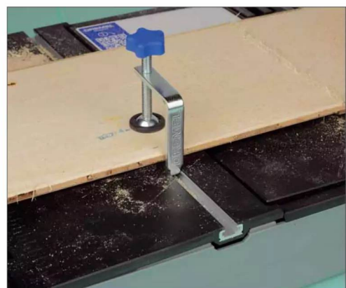
Für den sicheren Betrieb, werden die Werkstücke mit zwei Zwingen auf dem Säge Tisch fixiert
