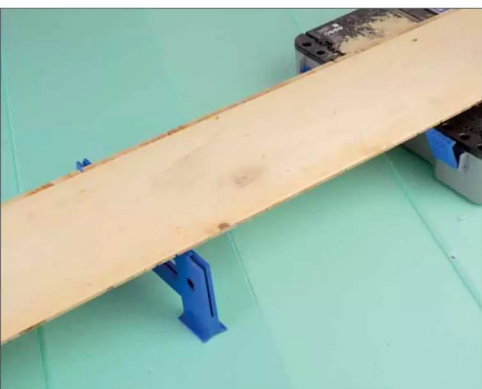
Im Zubehör der Station ist auch eine Materialstütze für überstehende Werkstücke vorhanden
