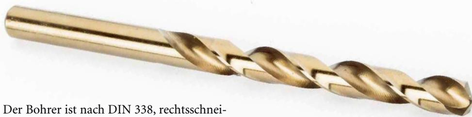
Der Bohrer ist nach DIN 338, rechtsschneidend gefertigt. Das Material ist Kobalt legiert. Es handelt sich um einen geschliffenen Bohrer. Durch die im Kreuzschliff gefertigte Spitze ist der Bohrer selbstzentrierend.
