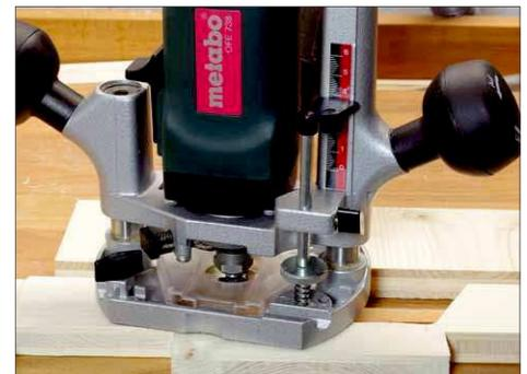
**9** Die Unterseite des Griffs haben wir schon einmal griffreudlich abgerundet. Mit einer Oberfräse mit Abrundfräser geht das sehr einfach. Manuell nimmt man am besten grobes Schleifpapier.
