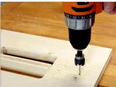
**10** Zum Befestigen stecken wir den Griff durch die Öffnung, richten ihn aus und bohren Löcher für die Schrauben vor. Damit das Holz um die Schraubenköpfe nicht reißt, ist eine Senkbohrung praktisch. Wir haben hier einen kombinierten Bohrer/Senkbohrer verwendet.
