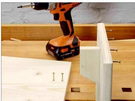
**22** Der Zusammenbau erfolgt ebenfalls fliegend. Positionen der Schrauben anzeichnen, vobohren, senken, Schrauben so weit eindrehen, dass die Spitzen herausragen, Leim angeben, Teile in Position bringen, verschrauben. Zuerst leimen wir die Steh- und Sitzfläche sowie die Stufe auf der einen Seitenwand fest, dann wird die zweite Seitenwand aufgeleimt.
