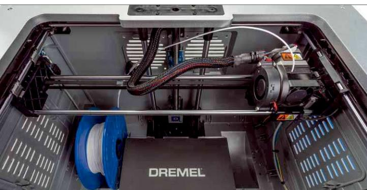
*Klar strukturiert: das Filament wird durch einen transparenten Schlauch zum Druckkopf geführt*
