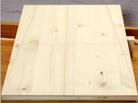
**1** Auf den Seitenteilen zeichnet man den Verlauf der Schrägen an: Das Trapez ist unten 35 cm, oben 25 cm breit. Wenn man schon dabei ist, zeichnet man gleich eine Linie in der Mitte, um die Höhe der Stufe zu markieren.
