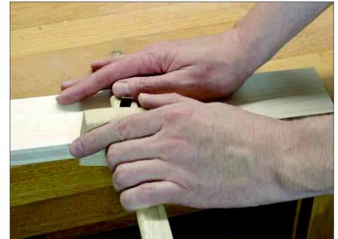
**6** Um den Griff einzupassen, zeichnen oder reißen wir zunächst längs eine 2 cm breite Linie an. Dieses Stück soll nacher durch das Griffloch hindurchragen. Bei der Materialstärke von 19 mm steht die Oberkante später zunächst 1 mm über. Die Breite des Griffstücks übertragen wir gleich von der ausgesägten Öffnung.
