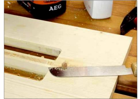
**15** Ist der Leim getrocknet, wird der überstehende Teil des Dübels abgesägt. Das geht am besten mit einer speziellen Dübelsäge, die nicht geschränkt ist und so keine Spuren auf dem umliegenden Holz hinterlässt. Aber auch mit einer normalen Säge kann man sich behelfen, indem man ein Stück Pappe, das etwas stärker ist als die Schränkung der Zähne, unter das Sägeblatt legt.
