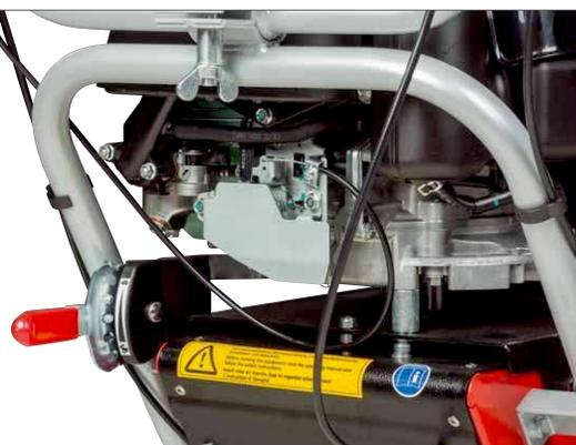
Der Verstellhebel unten am Motor regelt die Bürstendrehzahl in 5 Stufen
