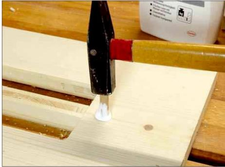
**13** Wenn der Leim abgetrocknet hat, werden die Schrauben Stück für Stück herausgedreht, das Schraubenloch mit einem 8-mm-Holzbohrer aufgebohrt und ein Holzdübel eingeleimt.
