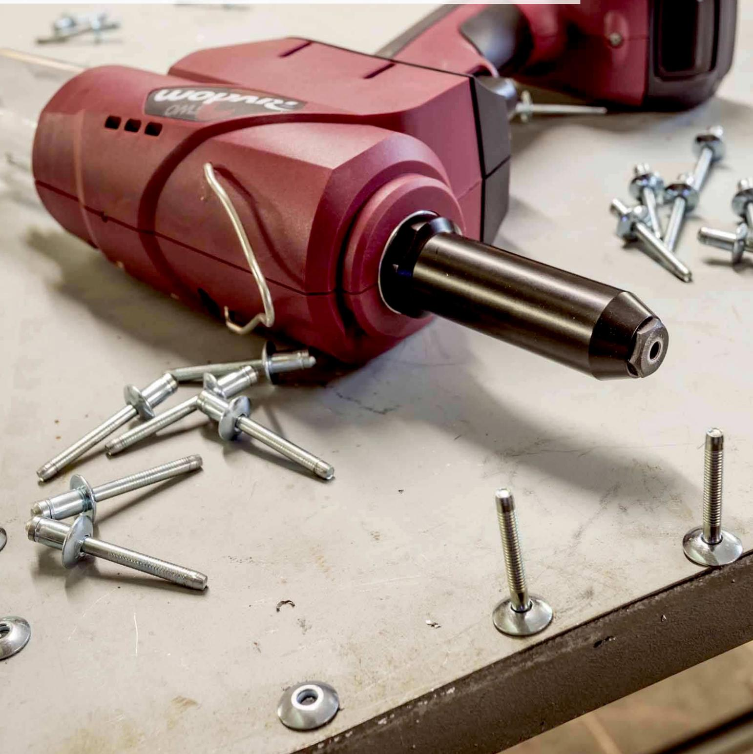
Es geht doch auch rein manuell. Stimmt, um mal schnell etwas mit ein paar Niete zu befestigen, ist das richtig. Sind aber große Niete über 5 mm zu setzen oder sind es viele Niete, dann ist schnell die Grenze der Handkraft erreicht. Für Serienbefestigungen wie sie z. B. bei Fassadenverkleidungen vorkommen, ist ein Akku-Nietgerät wie das Rivdom Two<sup>2</sup> eine sinnvolle Alternative zur Handzange.
