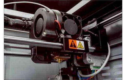
Der Druckkopf verfügt über zwei Ventilatoren, einer kann zur Beeinflussung des Drucks abgeschaltet werden
