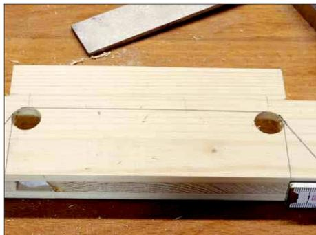
**8** Damit der Griff nicht so dick wird, haben wir von unten noch eine Taillierung angebracht. Die zwei Löcher markieren die Breite, dann wird an den Linien entlang ausgesägt.
