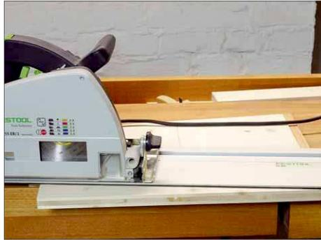
**2** Dann werden die Schrägen geschnitten. Das geht gut mit einer Handsäge, mit einer Handkreissäge mit Führungsschiene geht es schneller.
