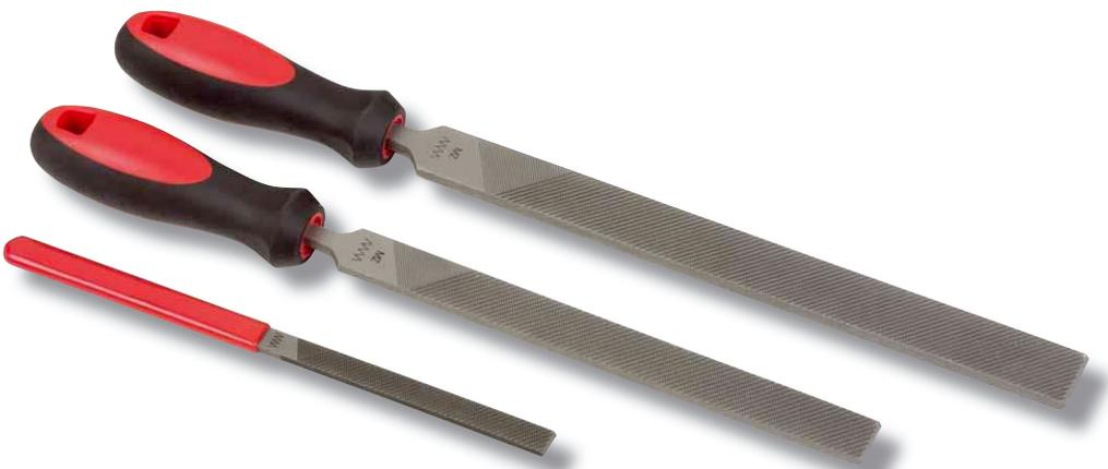
Die Feilen werden in drei Größen angeboten: 250 x 25 mm, 200 x 20 mm und in einer Mini-Version in 100 x 10 mm. Die beiden großen Varianten sind mit einem Zweikomponentengriff ausgestattet. Die Mini hat einen einfachen, gummierten Griff. Dick bietet die Feilen auch mit einfachem Kunststoffheft an. Die beiden Seiten der Feile sind je mit einem groben und einem feinen Hieb versehen. Als Hieb wird die Rauheit einer Feile bezeichnet.
