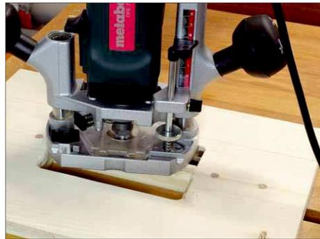
**17** Anschließend noch alle Kanten verrunden – praktischerweise wieder mit der Oberfräse mit Ab-rundfräser, sonst manuell mit Schleifpapier. Wo wir gerade dabei sind, runden wir noch alle weiteren sichtbaren Kanten – die der Seiten, der Stufe und die Unterseiten der Streben ab.
