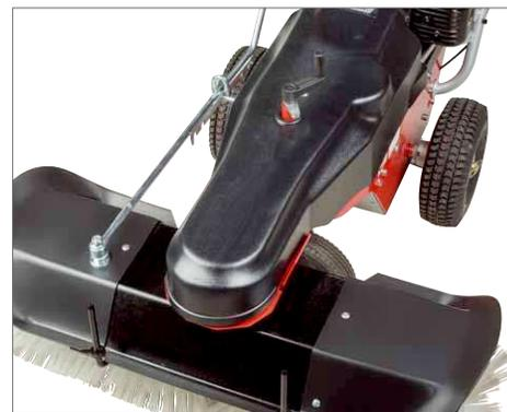
Die Bürste hat 100 cm Kehrbreite. Mit dem Hebel kann der Kehrwinkel im Betrieb verstellt werden
