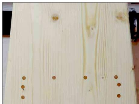
**23** Nach dem Trocknen des Leims werden alle Schrauben wieder durch Holzdübel ersetzt.
