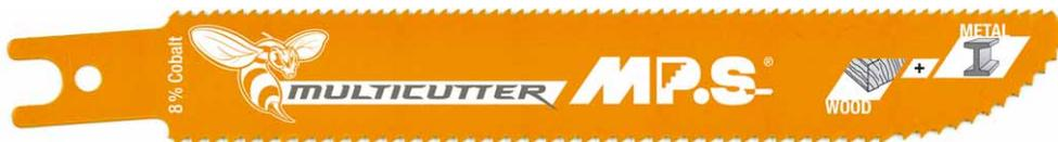
MPS, der Sägeblatt-Profi aus Wasserliesch, hat sich dazu einige Gedanken gemacht. Ergebnis ist ein Sägeblatt, das den Namen Multicutter trägt. Optisch fallen sofort die Form und die umlaufende Verzahnung auf. Die ist auf der Ober- und Unterseite verschieden, um unterschiedliche Materialien sägen zu können. Die Formgebung an der Blattspitze ermöglicht Tauchschnitte
