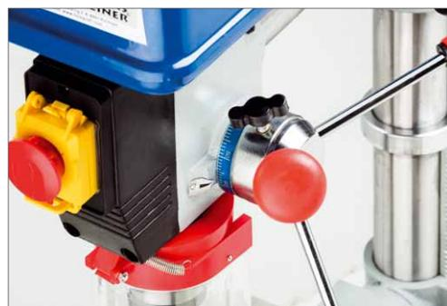
Eine mechanische Tiefeneinstellung erfolgt entweder per Gewindestange mit mm-Skala oder per Anschlagrad direkt am Dreiarms für die Spindelbedienung
