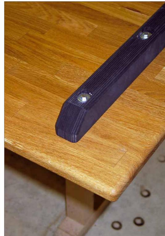
Die Schraubenköpfe der Schlossschrauben haben wir versenkt, damit sie nicht unter der Strebe hervorstehen. Einfach über den Langlöchern mit dem 20-mm-Nutfräser noch eine 5 mm tiefe Nut einfräsen
