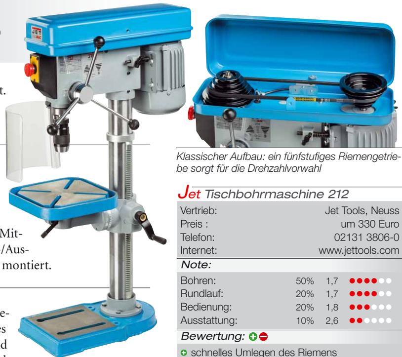
Klassischer Aufbau: ein fünfstufiges Riemengetriebe sorgt für die Drehzahlvorwahl
