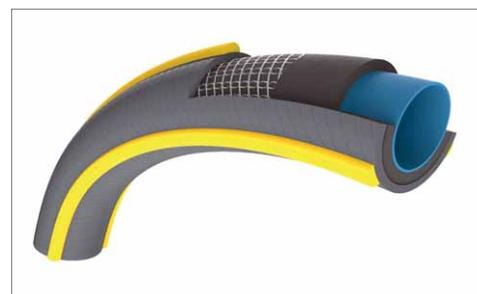
Man unterscheidet bei Schläuchen nach geflochtenen und gewebten Typen. Gewebte Schläuche haben eine deutlich dichtere Gewebeeinlage. Dadurch sind sie fester und bieten einen viel höheren Knickschutz. Auch in Sachen Verdrehsteifigkeit sind diese Schläuche deutlich besser.
