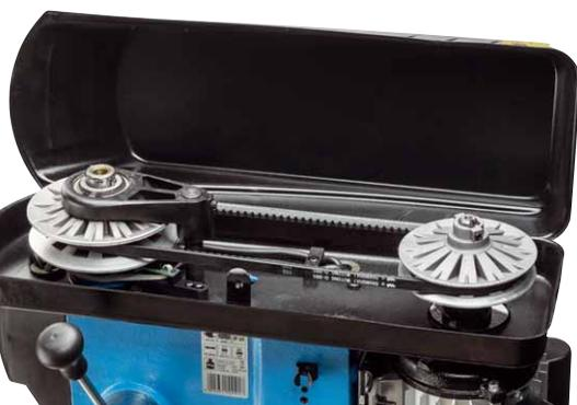
Ein variabler Riemenantrieb ermöglicht genaues Einstellen der Spindeldrehzahl
