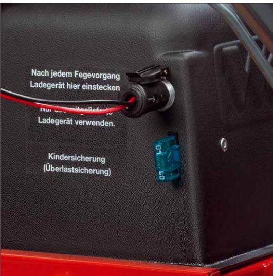
Geladen wird die Maschine per „Zigarettenanzünder-Stecker“ mit einem Ladegerät, das einen Überspannungsschutz hat. Die große 60-A-Sicherung schützt den Motor vor Überlast und erfüllt gleichzeitig die Funktion eines „Zündschlüssels“
