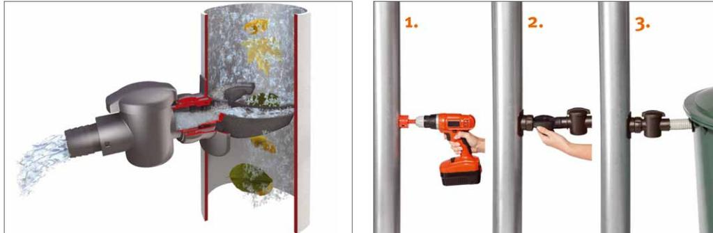
Mit nur drei einfachen Arbeitsschritten wird das Fallrohr angezapft. Schon kann das Regenwasser zum Gießen genutzt werden. Die Funktionsskizze zeigt das Prinzip
