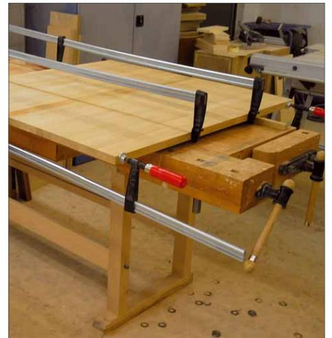
Die quadratische Tischplatte wird einfach aus zwei Stücken Arbeitsplatte zusammengesetzt, die mit den Längskanten aneinandergelimt werden
