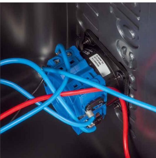
Ein paar Drähte und einen Zweiwegeschalter, mehr braucht es nicht, um den Rechts-Links-Lauf der Maschine zu steuern
