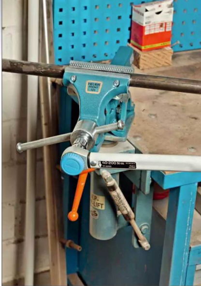
Die Nutzung einer Ratsche zum schnellen Arbeiten oder eines Drehmomentschlüssels zum präzisen Arbeiten ist jetzt problemlos möglich
