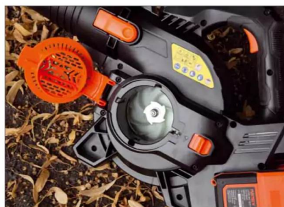
Hier der Blick auf das Lüfterrad mit dem Häckselmesser. Die Maschine lässt sich logischerweise nur bei geschlossener Klappe oder mit aufgestecktem Saugrohr einschalten
