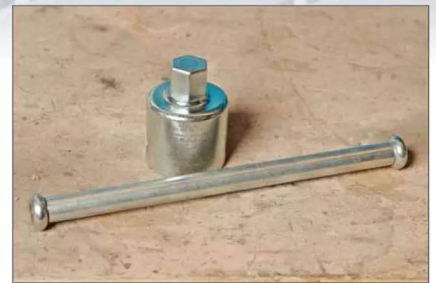
Das Set mit dem Sechskantaufsatz besteht aus der Hülse mit Sechskant, sowie einer neuen Kurbel mit Gewinde-Endstück
