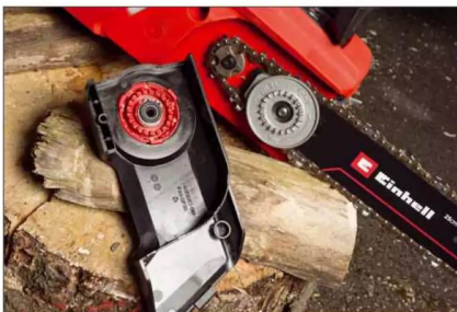
Die Kettenspannung wird werkzeuglos über das Exzenterrad am Schwert eingestellt
