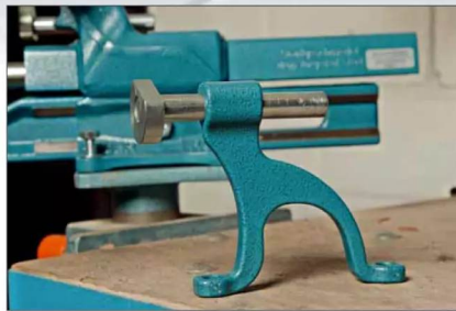
Die Auflageböcke können nachträglich am Schraubstock angebracht werden
