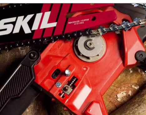
Die Kettenspannung wird per Federbolzen, der auf das Schwert wirkt, eingestellt
