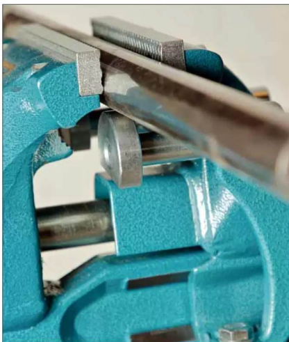
Die Auflagekonusse begrenzen präzise die Eintauchweite des Werkstücks. Dabei ist die Werkstückdicke unerheblich
