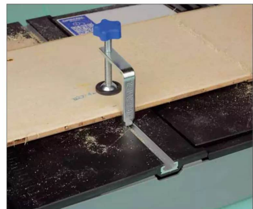
Für den sicheren Betrieb, werden die Werkstücke mit zwei Zwingen auf dem Sägertisch fixiert
