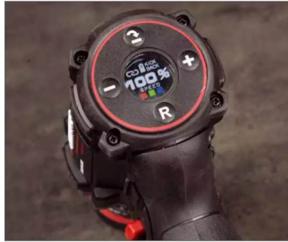
Über die Taster am Display können der Kickback-Schutz, die Bluetooth-Verbindung zur App und die Drehzahl ein- und ausgeschaltet bzw. eingestellt werden
