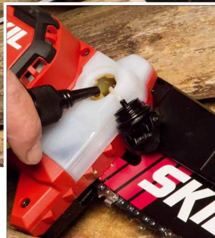
Mit ihrer automatischen Kettenschmierung ist die Skil eine Ausnahme unter den Astsägen
