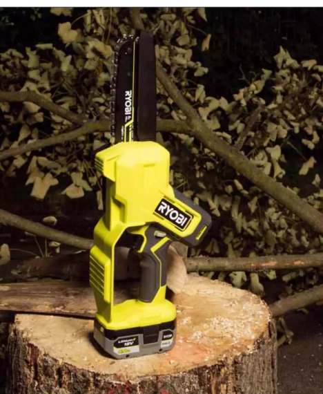
Als einzige Säge im Test kann die Ryobi RY18 PS15A abgestellt oder abgelegt werden, ohne dass die Kette Bodenkontakt hat
