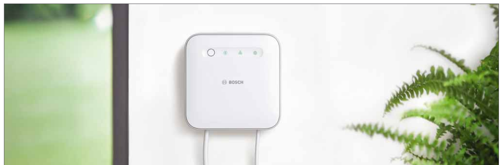
Das Herz der Anlage ist der Smart Home Controller II bei ihm laufen die Daten zusammen und über ihn erfolgt die Kommunikation mit den Nutzern
