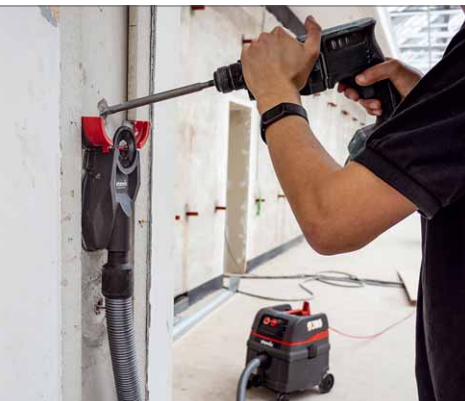
Ausklappbare Seitenflügel vergrößern den Absaugbereich
