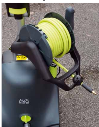
Mit einer schwenkbaren Schlauchtrommel wird die Arbeit noch einmal vereinfacht, weil das Gerät nicht so schnell umkippt, wenn am Schlauch gezogen wird
