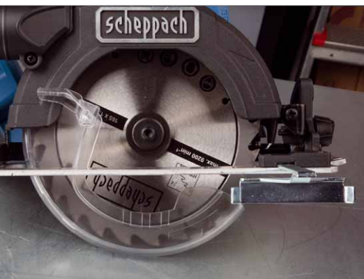
Die Fußplatte der Säge ist 4 mm dick
