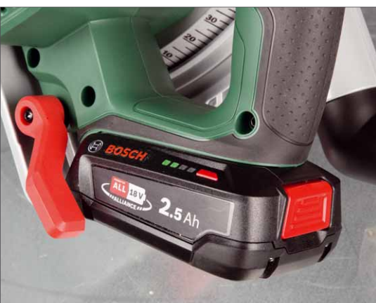
Die neuen Bosch Akku verfügen endlich über eine Ladezustands-Anzeige
