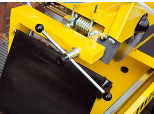
Der große Knebelgriff sorgt für die sichere Positionierung des Scheidkopfs bei Gehrungsschnitten
