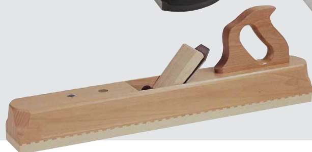
Auch Raubänke gibt es aus Holz oder Eisen. Die Eisenbreite liegt hier bei 60 mm
