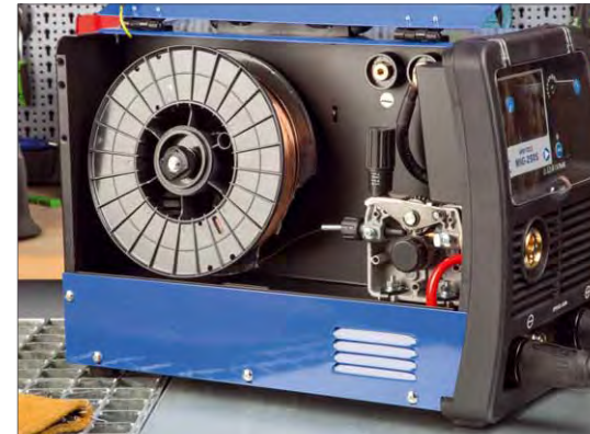
Drahtrollen bis zu einem Durchmesser von 200 Millimetern können hier verwendet werden
