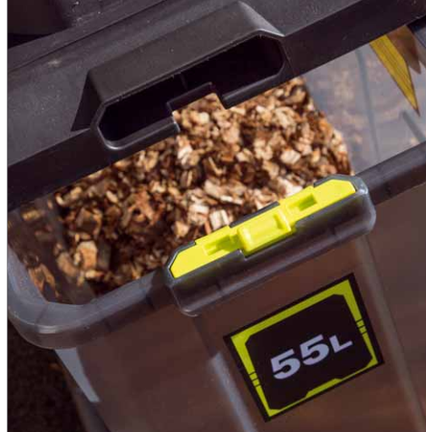
Die Box für das Häckselgut fasst 55 l. Eine Sicherheitsschaltung lässt den Motor bei geöffneter Box nicht anlaufen
