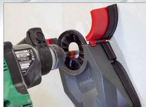
Geöffnete Flügel ermöglichen bessere Sicht auf den Bohrbereich, so können aber auch kleine Meißelarbeiten erledigt werden
