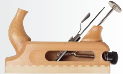
Auch Holzhobel gibt es mit einer Mechanik zur Eisenfeinverstellung. Dieses Schnittmodell zeigt, wie das Eisen von hinten in den Hobelkörper geklemmt wird, während die Schraube von oben die Höheneinstellung ermöglicht
