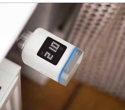
Die alten einfachen Heizungsthermostate werden durch smarte ersetzt
