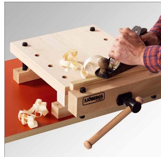
Wer wenig Platz hat, für den sind solche Hobelbankaufsätze eine Alternative, die sich auch schnell wieder abbauen lässt
