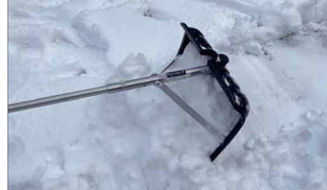
Durch die Auskehlung des Räumschildes wird der Schnee sauber von der Fläche gezogen
