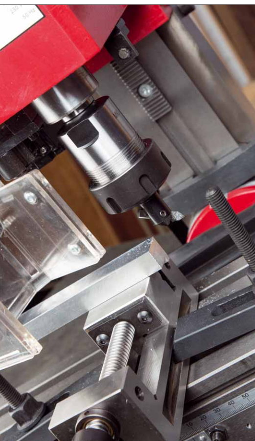
Natürlich wird die Maschine beim öffnen der Schutz-abdeckung sofort gestoppt und ein Wiederanlauf-schutz verhindert den Neustart beim Schließen der Abdeckung
