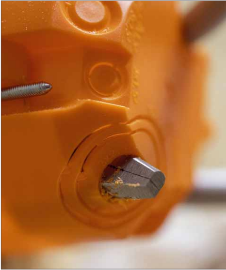
Auch das Aufweiten von Kabeldurchführungen z.B. in Installationsdosen gelingt mit der Multifunktionszange-8in1 electric ganz einfach
