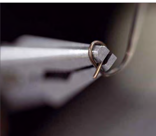
Ösen biegen gelingt ebenfalls ganz einfach
