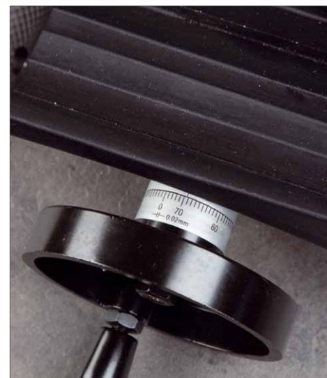
Mit diesen gut ablesbaren Skalen sind sowohl der Verfahrweg in X- und in Y-Richtung ausgestattet
