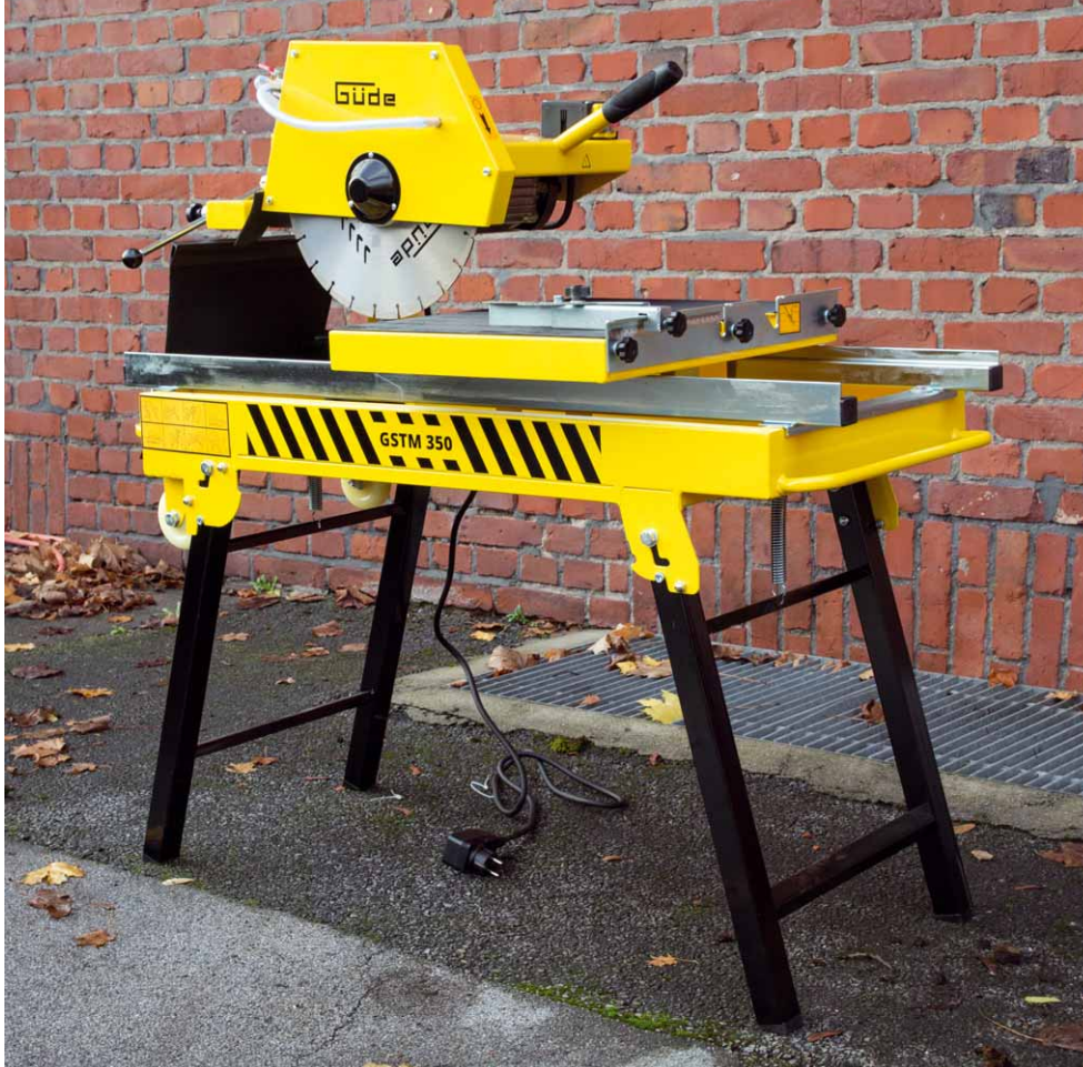
Für den Transport können die Beine eingeklappt und die Maschine auf den Rollen bewegt werden
