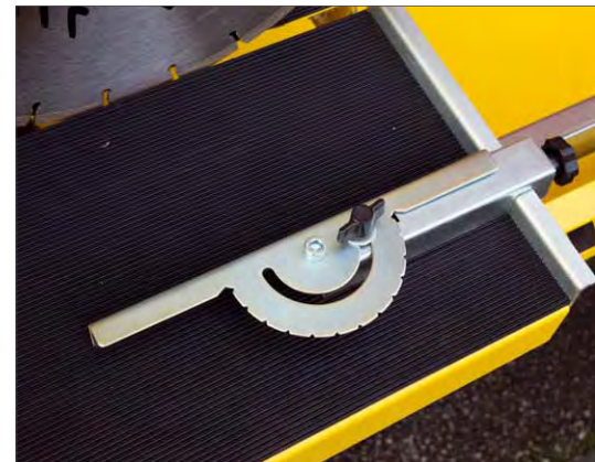
Mit Längs- und Parallelanschlag, kann das Werkstück präzise für den Schnitt ausgerichtet werden
