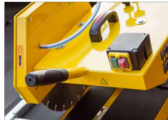
Der Schalter ist gegen Spritzwasser geschützt und leicht zugänglich. Zur Sicherheit ist im Zuleitungskabel noch ein Personenschutzadapter verbaut
