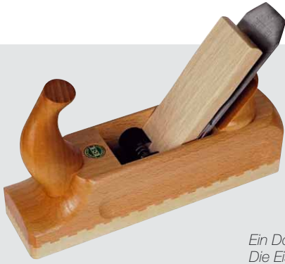
Ein Doppelhobel in traditioneller hölzerner Bauart. Die Eisen werden durch einen Keil im Hobelkörper fixiert. Das Keilwiderlager ist modern gebaut
