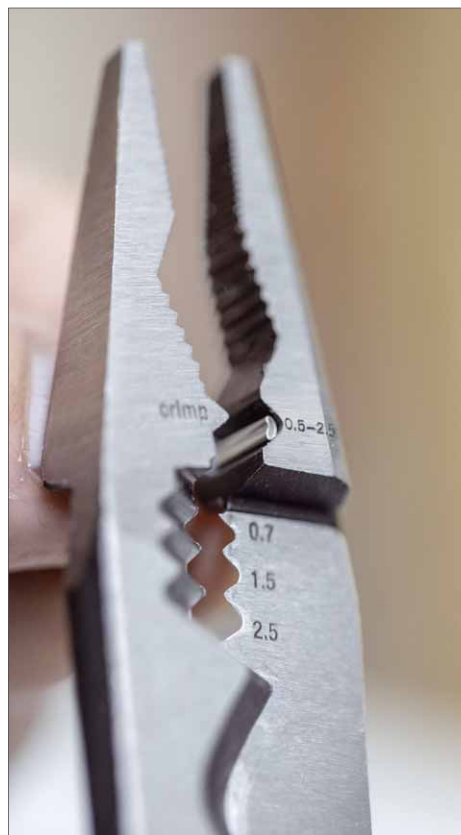
Auch Aderendhülsen lassen sich fachgerecht crimpen
