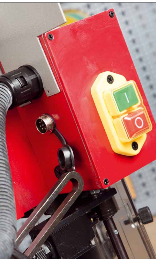
Hier am Elektrokasten kann auch optionales Zubehör, wie zum Beispiel eine Digitale Drehzahl-anzeige angeschlossen werden
