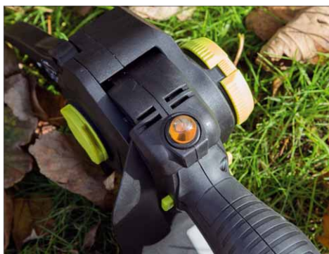
An der rechten Maschinenseite erkennt man den Feststeller für die Verstellung des Kopfwinkels. Oben die Handpumpe für die Kettenschmierung
