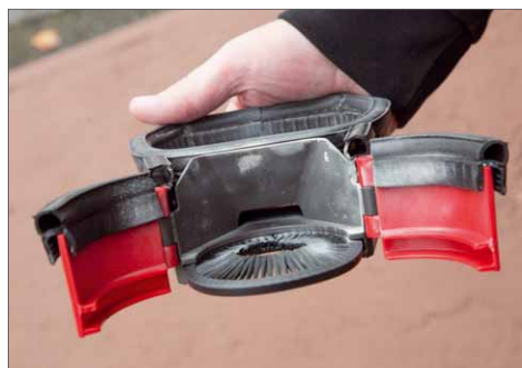
Die aufgesteckten Dichtungen lassen sich bei Beschädigung schnell erneuern
