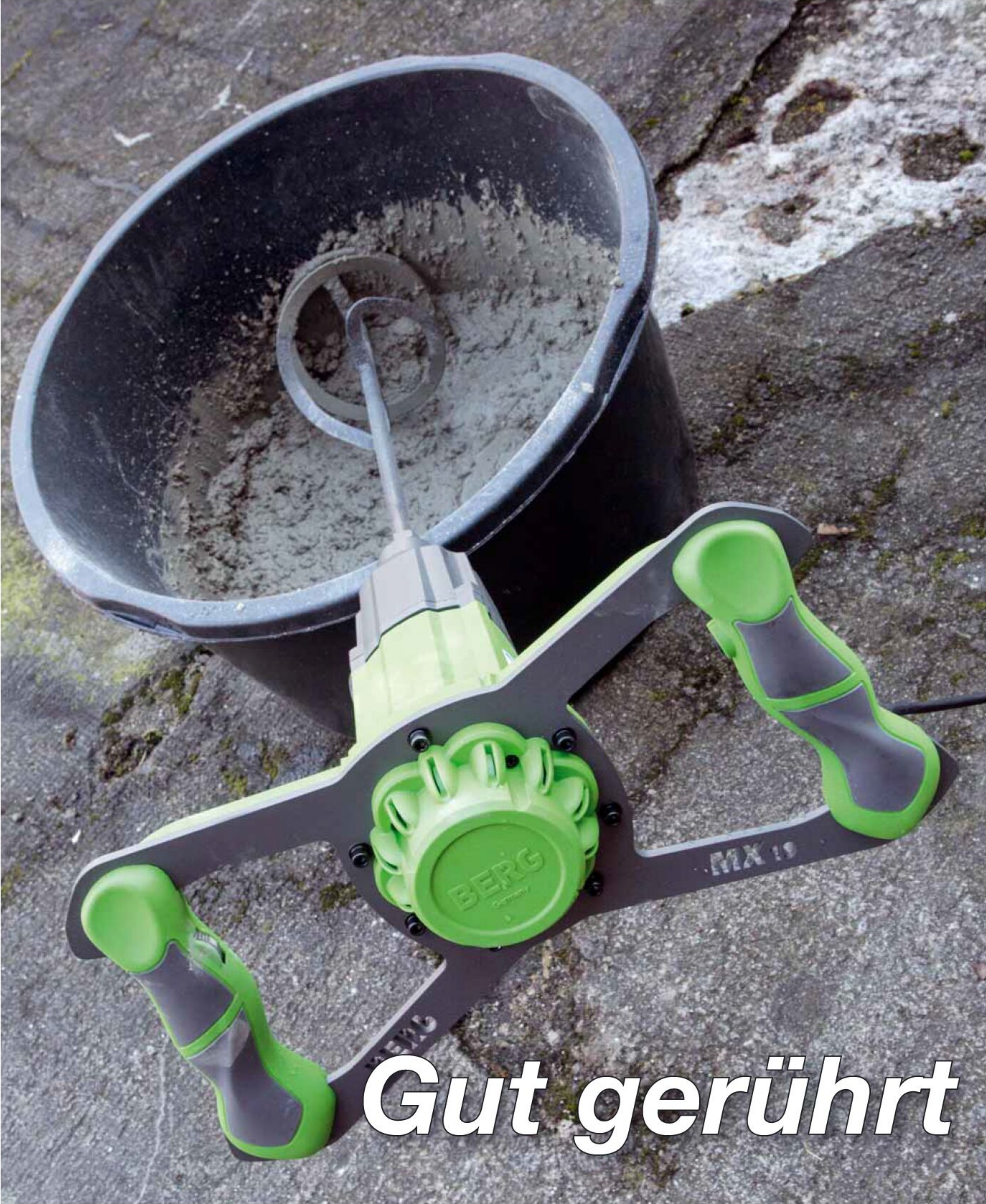
Mit den Stahl verstärkten Griffen lässt sich das Gerät sicher halten und gut führen
