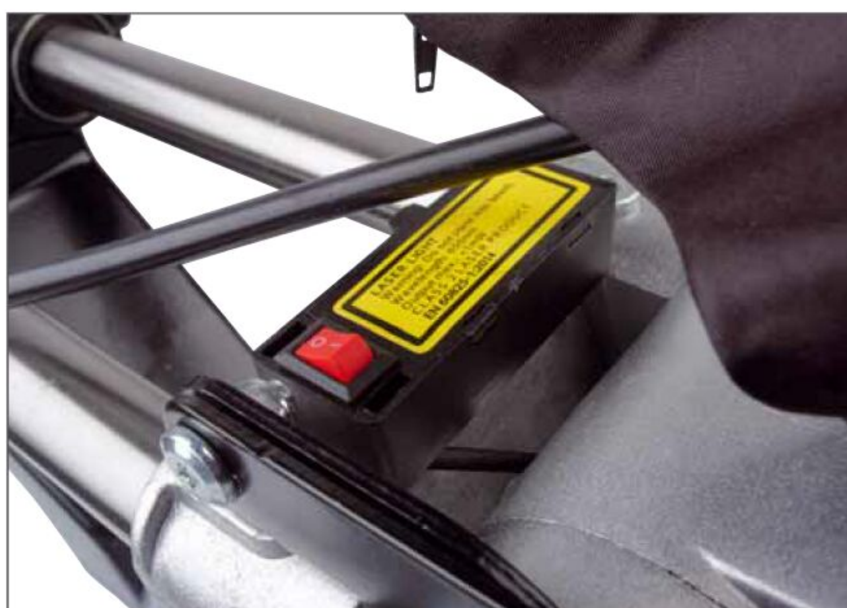
Der Schnittlinienlaser ist direkt hinter dem Sägekopf montiert
