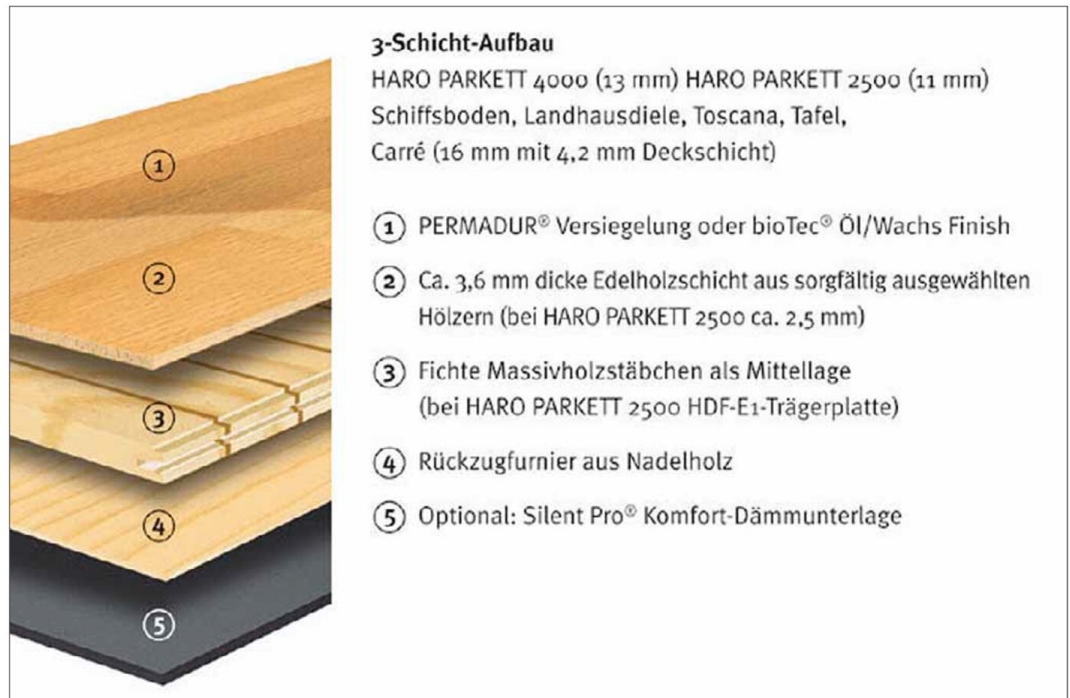
Aufbau eines typischen Klickparketts, hier aus dem Hause Haro
