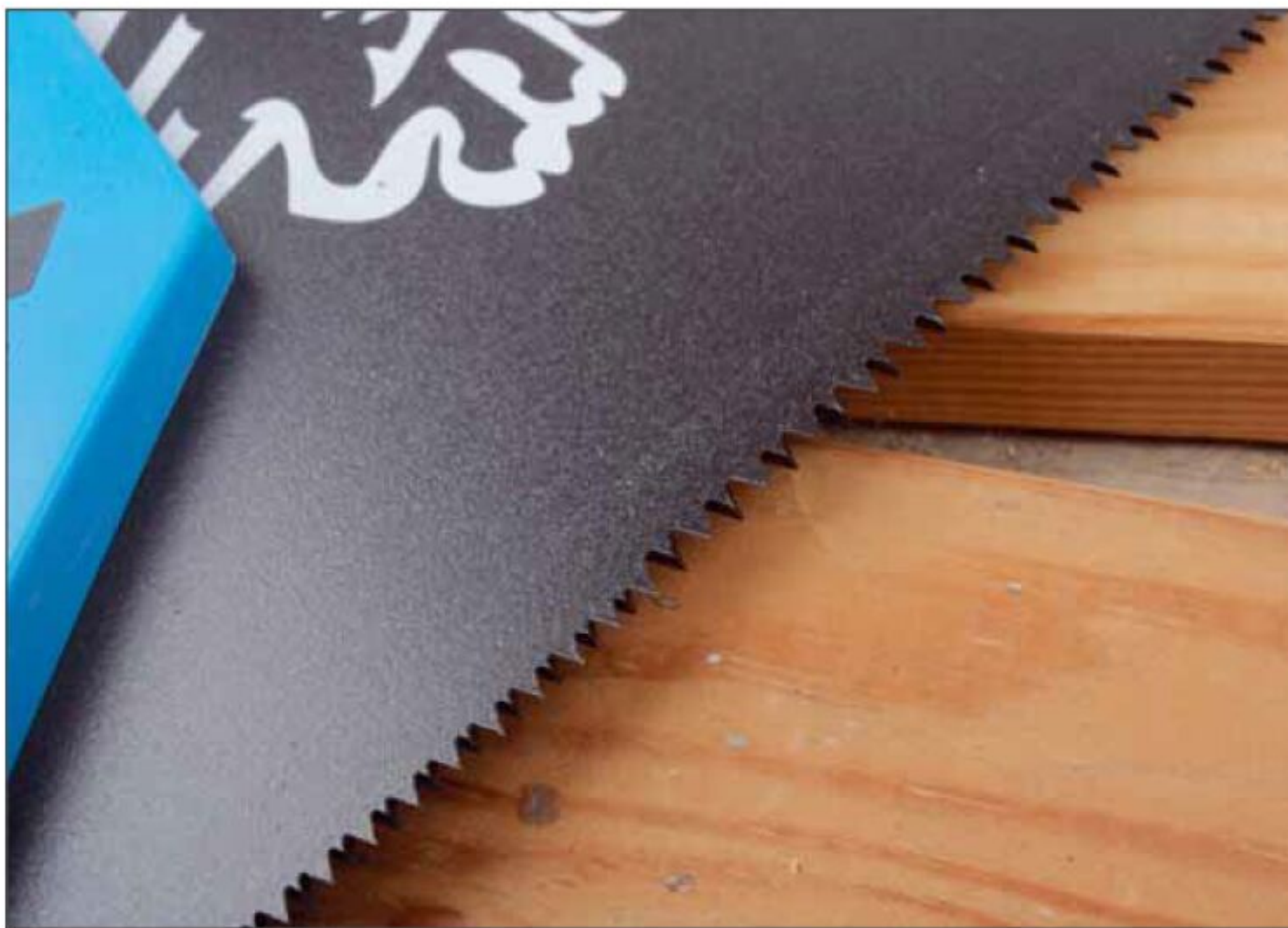
Vorn und hinten befindet sich auf jeweils 65 Millimetern eine Feinzahnung zum Ansetzen des Schnitts
