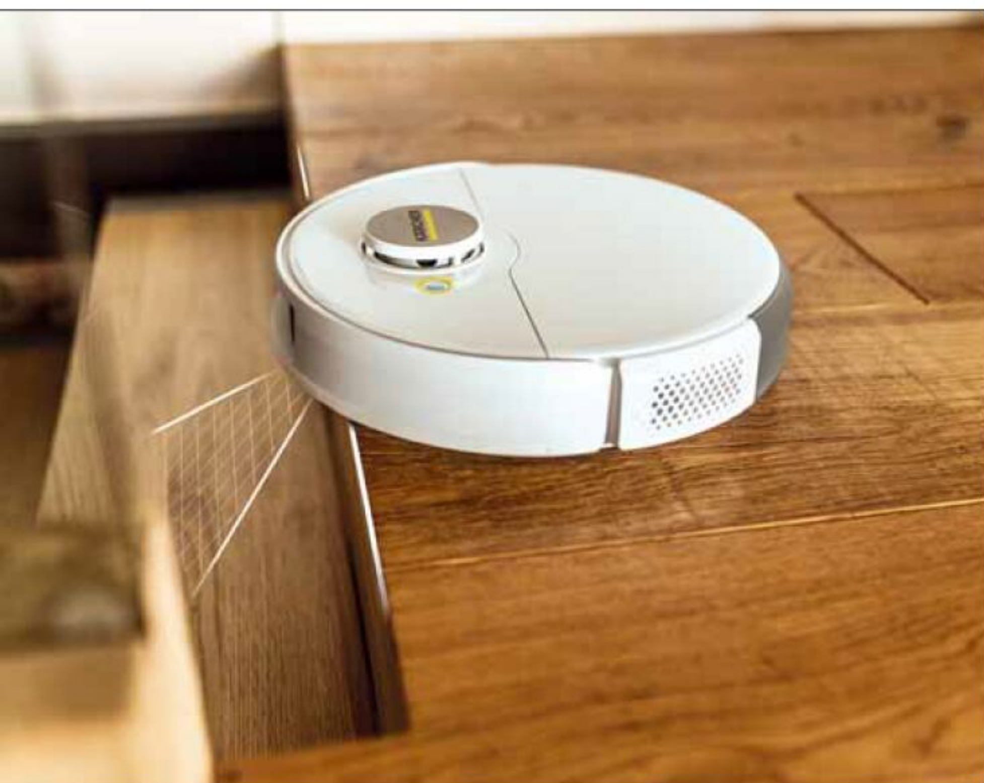
Die Sensoren erkennen Treppenabsätze und lassen den RCV5 umkehren
