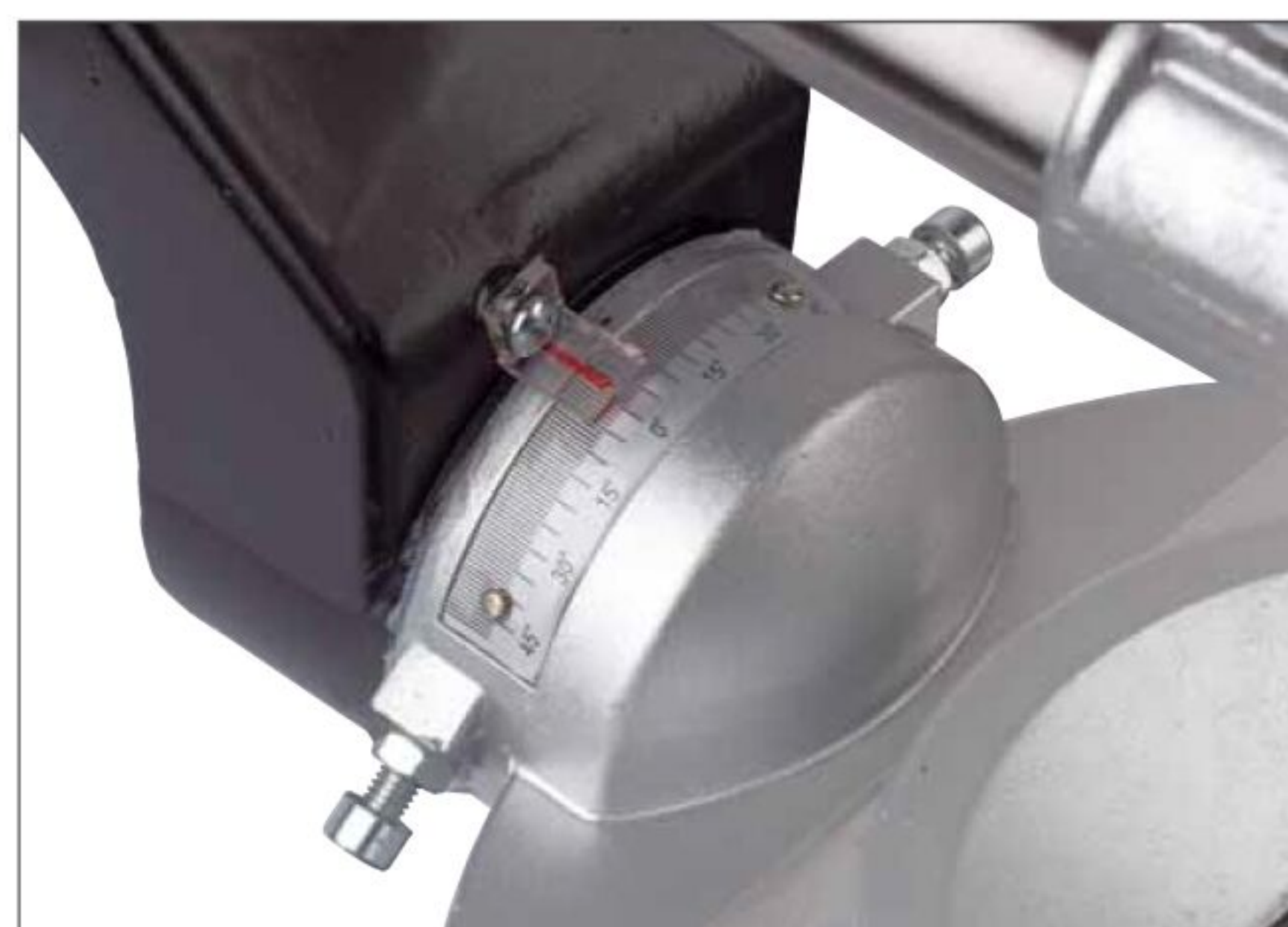
Die Winkelskala ist recht kleinteilig und erfordert genaues Hinsehen
