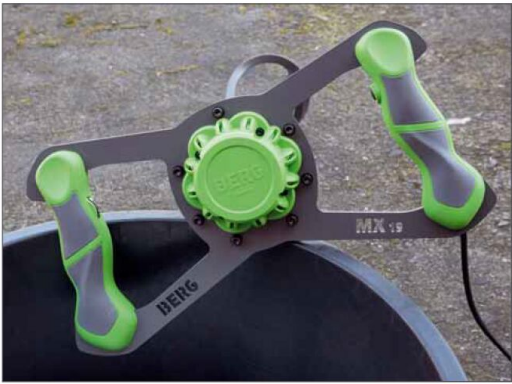
Mit den Stahl verstärkten Griffen lässt sich das Gerät sicher halten und gut führen
