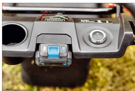
Die wechselbaren Startakkus passen auch in alle anderen 20V-Scheppach Geräte
