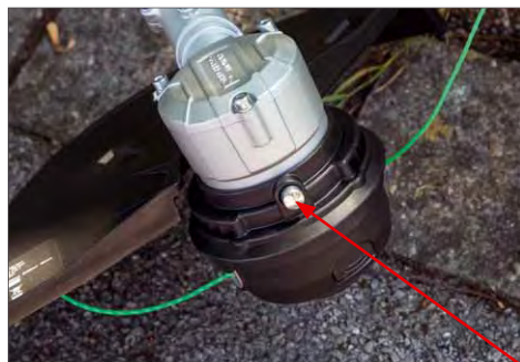
Die Spindelarretierung (Pfeil) erleichtert den Werkzeugwechsel deutlich. Am Freischneider findet man das eher selten
