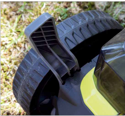
Die Arbeitstiefe wird in drei Stufen per Handhebel eingestellt
