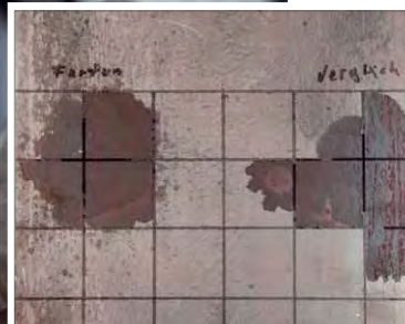
die beinahe kreisförmige Kriechwirkung von Fertan (links) sorgt für gleichmäßige Verteilung des Wirkstoffs
