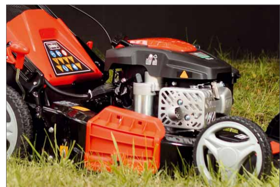
Hinter dem Auspuff erkennt man den Anlasser für den Motor. Im Notfall kann auch per Anreißleine gestartet werden
