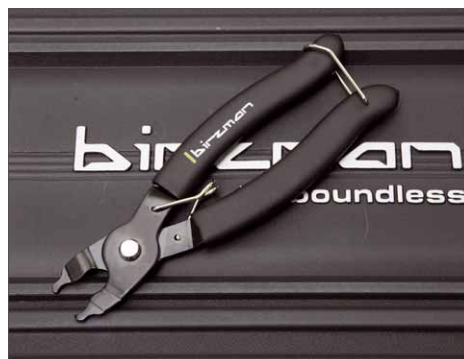
Eine Kettenschloßzange macht den Kettenwechsel deutlich leichter
