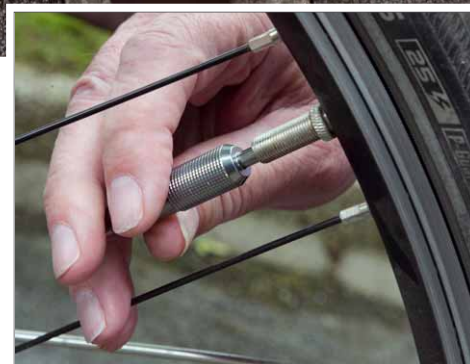
Der Ventilausdreher passt für alle drei gängigen Ventiltypen
