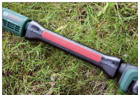
Der Dreh-Zugschalter ist ungewöhnlich, funktioniert aber bestens
