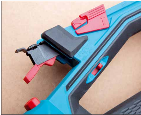
Der kleine Schieber gibt die Serienklammerung frei, der große Schieber dient als Anschlag um die Klammern optisch sauber zu setzen.
