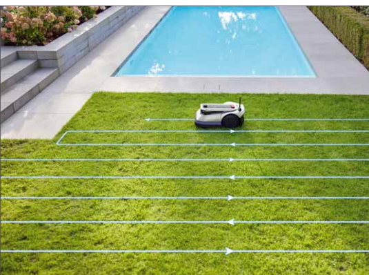
Im Gegensatz zu vielen anderen Roboter-mähern arbeitet dieser beim Mähen mit einem Linienmuster
