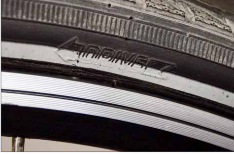
Neben dem Reflektorstreifen auf dem Reifen erkennt man hier noch den Laufrichtungspfeil der bei der Reifenmontage beachtet werden sollte
