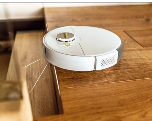
Die Sensoren erkennen Treppenabsätze und lassen den RCV5 umkehren
