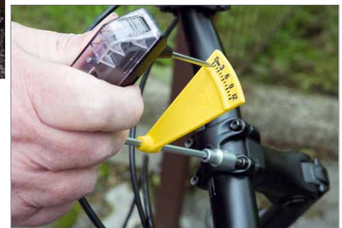
Einfach, aber funktional: der Torsions-Drehmomentschlüssel mit integriertem Bithalter
