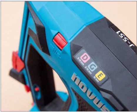
Der kleine Drehregler vorn am Gerät stellt die Einschlagtiefe der Klammern
