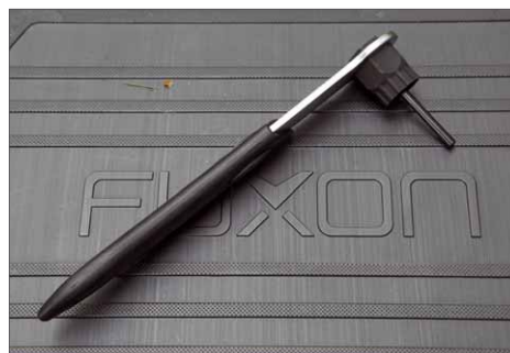
Das Lösewerkzeug für die Ritzelkassette wird komplett mit Hebel geliefert
