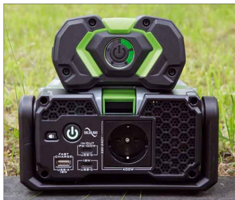
Das Bedienfeld erklärt sich selbst. Lediglich der USB C 2 Port kann auch zum Laden verwendet werden, alle anderen sind nur Ausgänge
