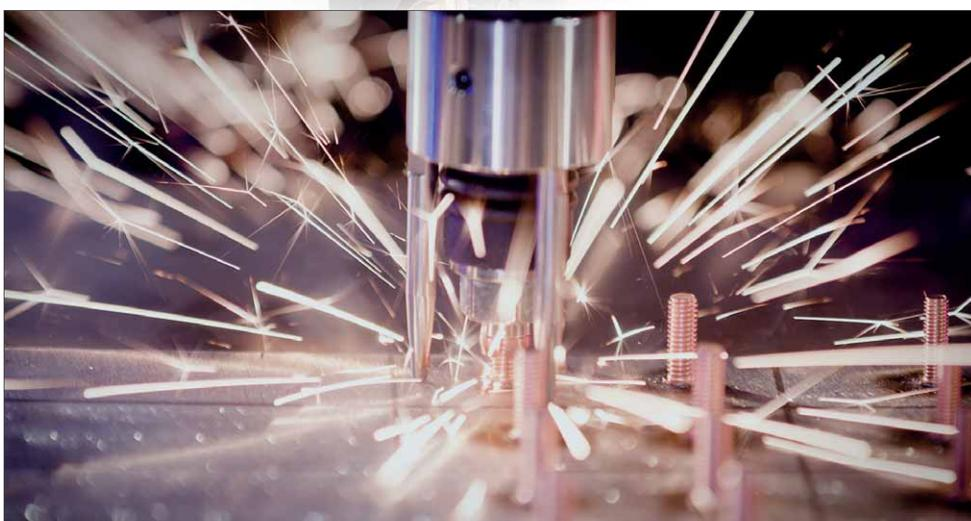
Durch den kurzen Schweißimpuls wird der Zugbolzen fest mit dem Metall verschweiß
