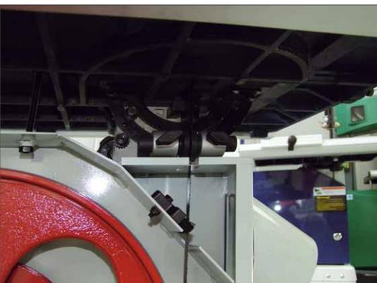
Auch die untere Bandführung ist hochwertig mit Rollen bestückt. Die Tischneigung wird bequem von der Rückseite per Handrad eingestellt
