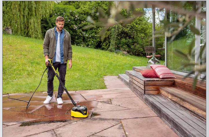
Für die Entfernung von Moos und Grauschleier auf Holzterrassen, WPC-Dielen und ähnlich empfindlichen Materialien können Terrassenreiniger eingesetzt werden, die Verschmutzungen mit einer Kombination aus Wasser und schnell rotierenden Bürstenwalzen lösen und abspülen.
