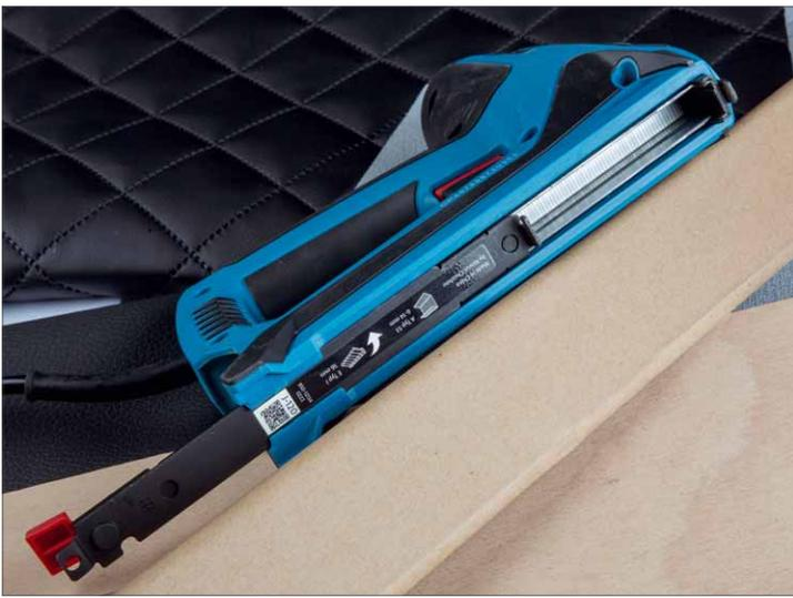
Bei beiden Tackern werden die Klammern von unten ins Magazin eingelegt
