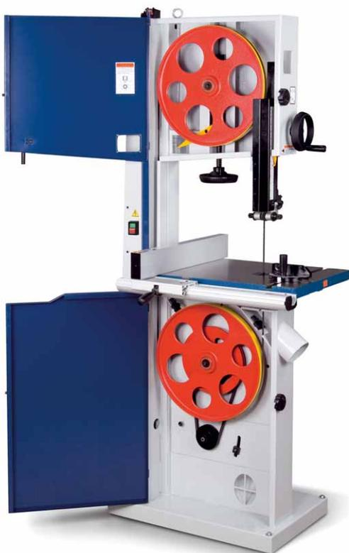
Die massiven Guss-Bandrollen sorgen dank reichlich Schwungmasse für leisen und gleichmäßigen Lauf der Maschine
