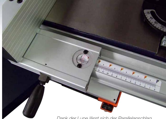
Dank der Lupe lässt sich der Parallelanschlag auf den Millimeter genau einstellen
