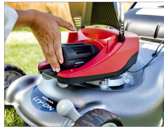
Klappe auf, Akku rein, Klappe zu. Die Bedienung von Akkumähern ist sehr einfach, wie bei diesem Modell der izy-ON-Reihe von Honda
