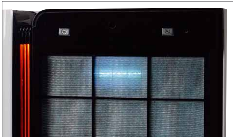
Das eingeschaltete UV-Licht aktiviert den Titanoxidfilter, der Bakterien und Viren abtötet. Ohne UV-Licht bleibt der Filter wirkungslos
