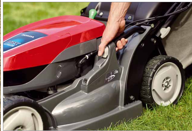
Komfortable Bedienelemente erleichtern die Arbeit. Gut gelöst: Beim Honda HRX 476 XB lässt sich die Schnitthöhe zentral mit einem Handgriff einstellen
