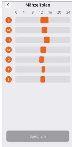
Der Zeitplan für die Arbeitszyklen wird auf dem Smartphone in wenigen Minuten erstellt, zum Schluß genügt ein Tipp auf die Speichertaste um die Daten an die Maschine zu senden
