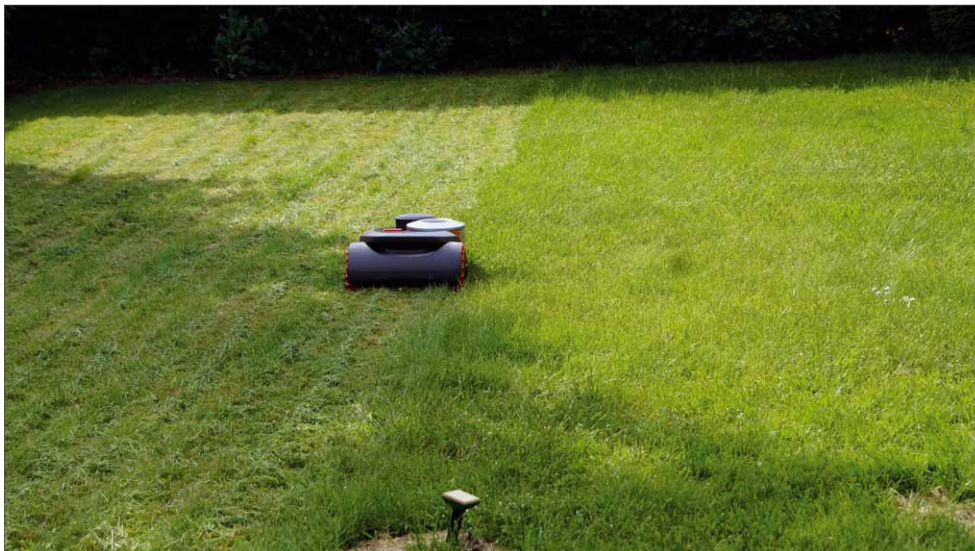
Hier erkennt man gut, dass die Maschine in leicht überlappenden geraden Bahnen arbeitet
