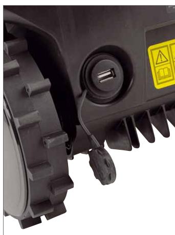
Software-Updates finden per USB-Stick den Weg auf die Maschine
