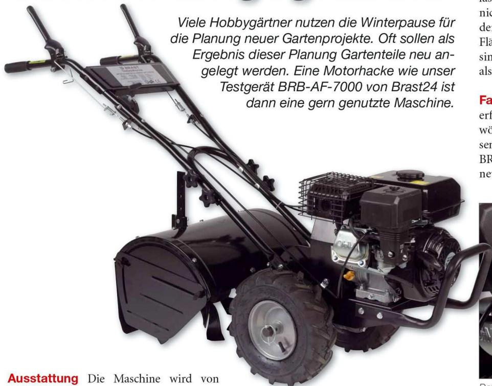
**Ausstattung** Die Maschine wird von einem Benzinmotor mit 4,1 kW (5,6 PS) angetrieben. Der Motor treibt über einen Getriebekblock sowohl die Räder als auch über eine Kupplung die Messerwelle an. Die Arbeitsbreite beträgt 50 cm, Als Arbeitstiefe gibt der Vertrieb 17,5 cm an.
