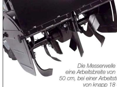
Die Messerwelle hat eine Arbeitsbreite von ca. 50 cm, bei einer Arbeitstiefe von knapp 18 cm
