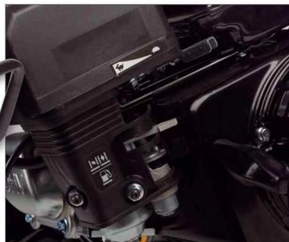
Der Vergaser vorn an der Maschine verfügt ganz klassisch über einen Choke und einen integrierten Benzinbahn
