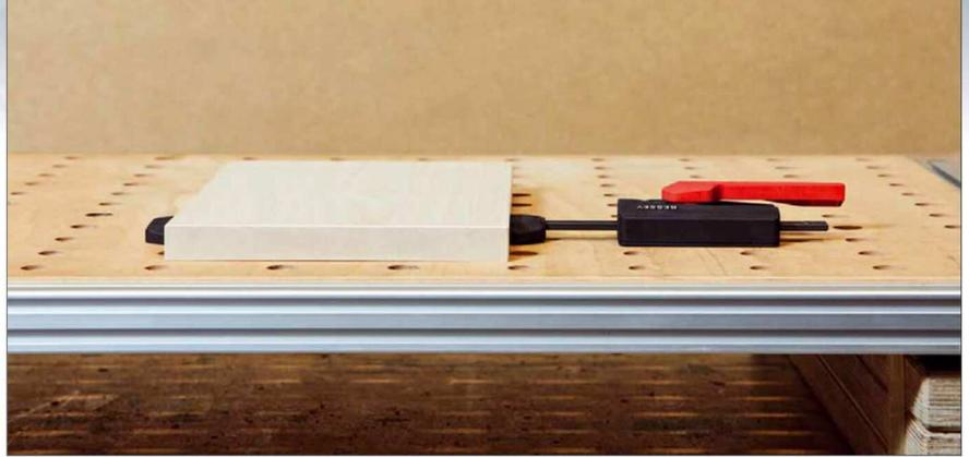
Der Horizontalspanner hat eine hohe Steifigkeit, so dass das Werkstück genau in der Ebene bleibt ohne sich hoch zu drücken
