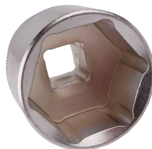
Sauber gefertigt sind die Sechskant-Nüsse mit ausgefrästen Ecken
