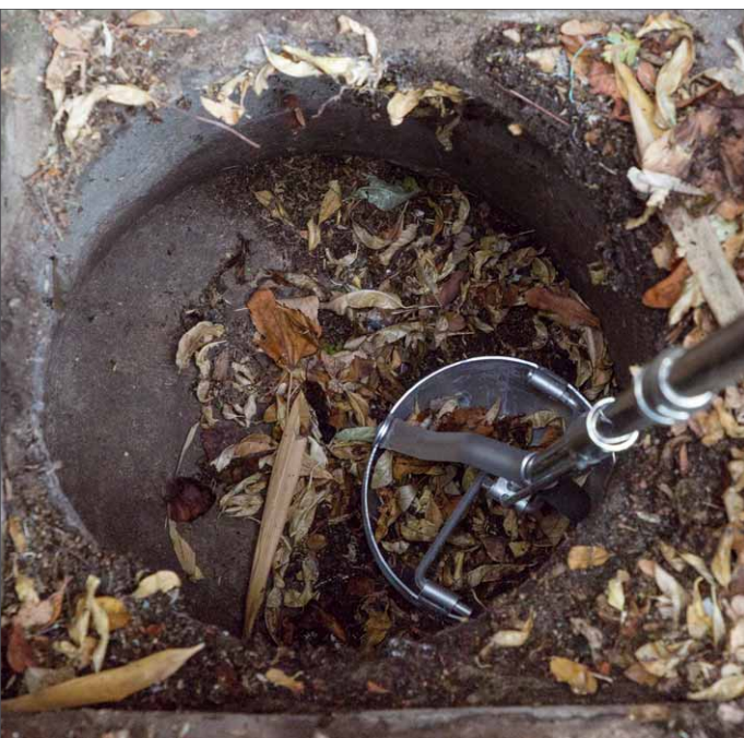
Mit dem Imku-Sielreiniger lässt sich prinzipiell unbeliebtes Reinigen von Abflüssen schnell erledigen
