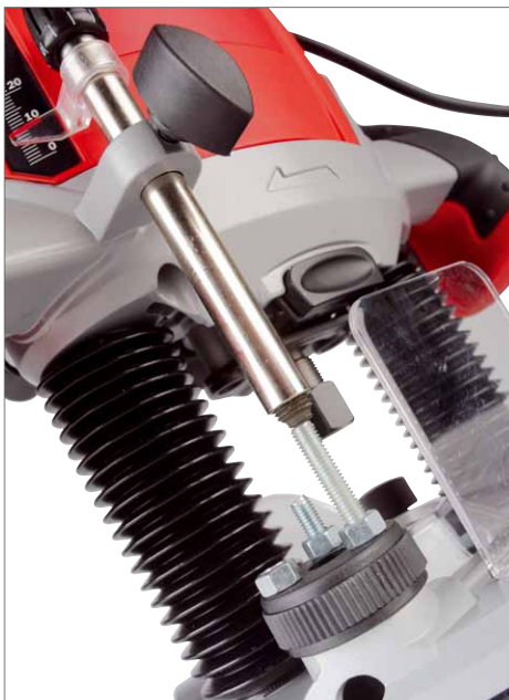
Der Stab zur Tiefeineinstellung der Einhell TE-RO 1255 E besitzt innen einen Gewindestift, der die Feineinstellung der Frästiefe erlaubt.
