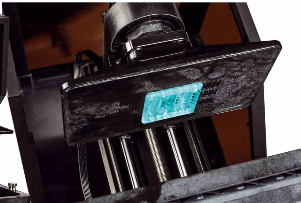
Das Modell entsteht bei einem SLA-Drucker in der Resin-Flüssigkeit und wird nach oben herausgearbeitet
