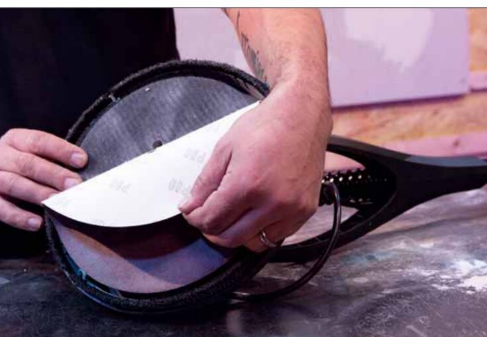
Das Schleifblatt wird mit einem Klettverschluss befestigt
