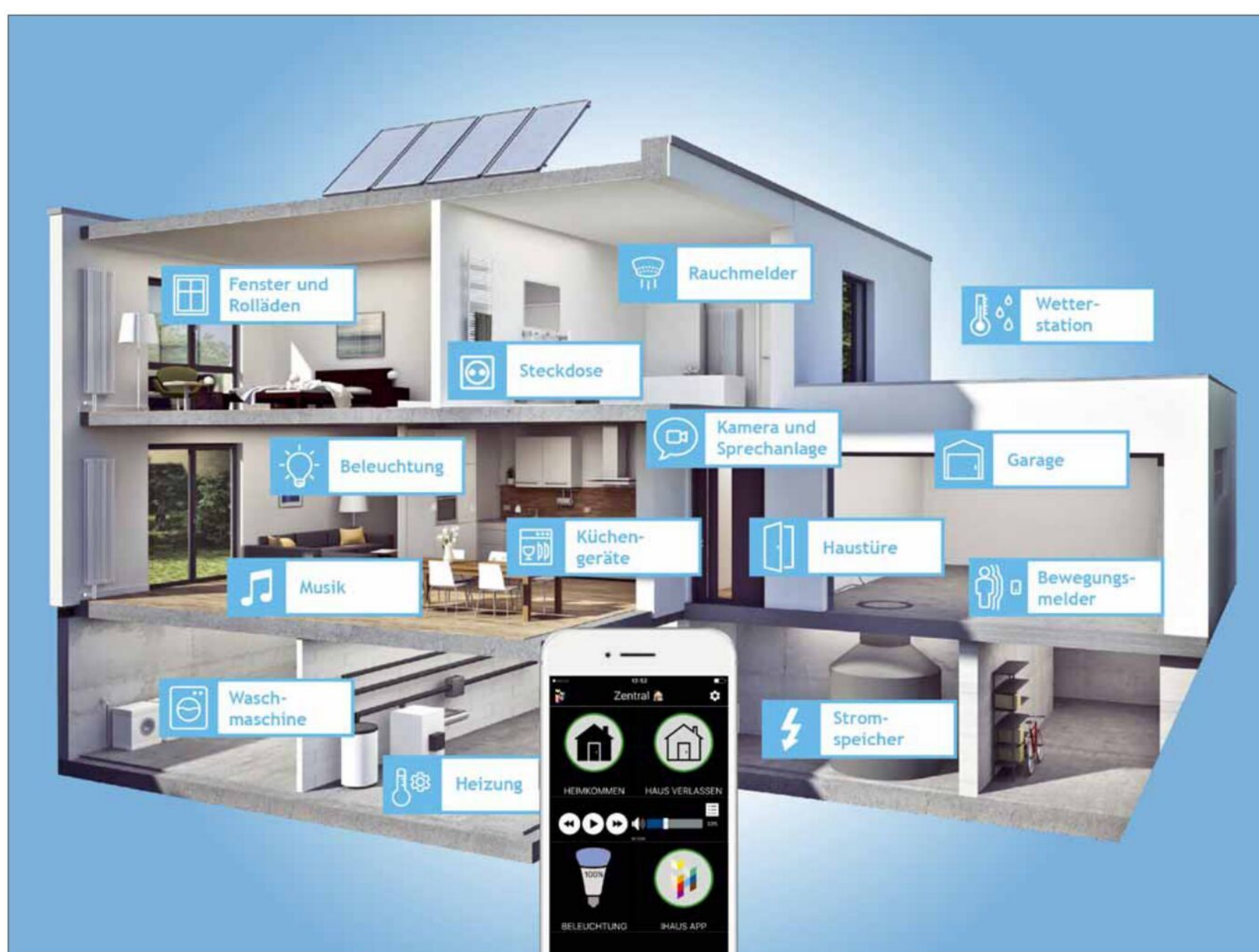
Moderne Smart Home Steuerungen können neben Temperatur und Luftfeuchtigkeit viele weitere Komponenten in Haus und Wohnung steuern
